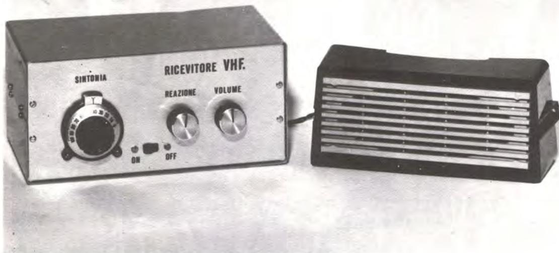
Fig. 7 Coloro che desiderano le cose perfette, potranno come abbiamo fatto noi racchiudere il tutto entro un elegante mobiletto metallico (completandolo con l'altoparlante presentato a pag. 190 del n. 3/69 di nuova Elettronica). Le scritte sul pannello sono state effettuate con lettere autoadesive rintracciabili presso ogni cartoleria.
