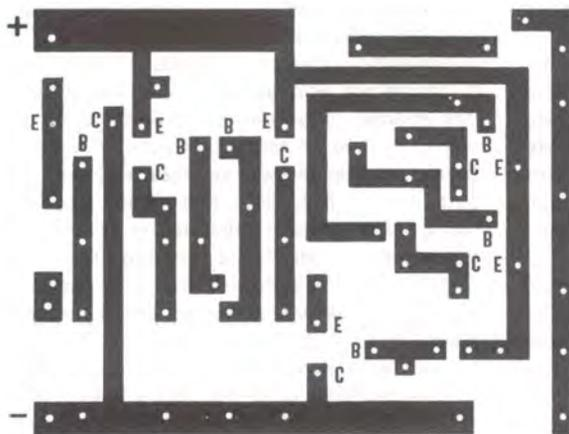
Fig. 2 Nel disegno viene rappresentato in grandezza naturale il circuito stampato
