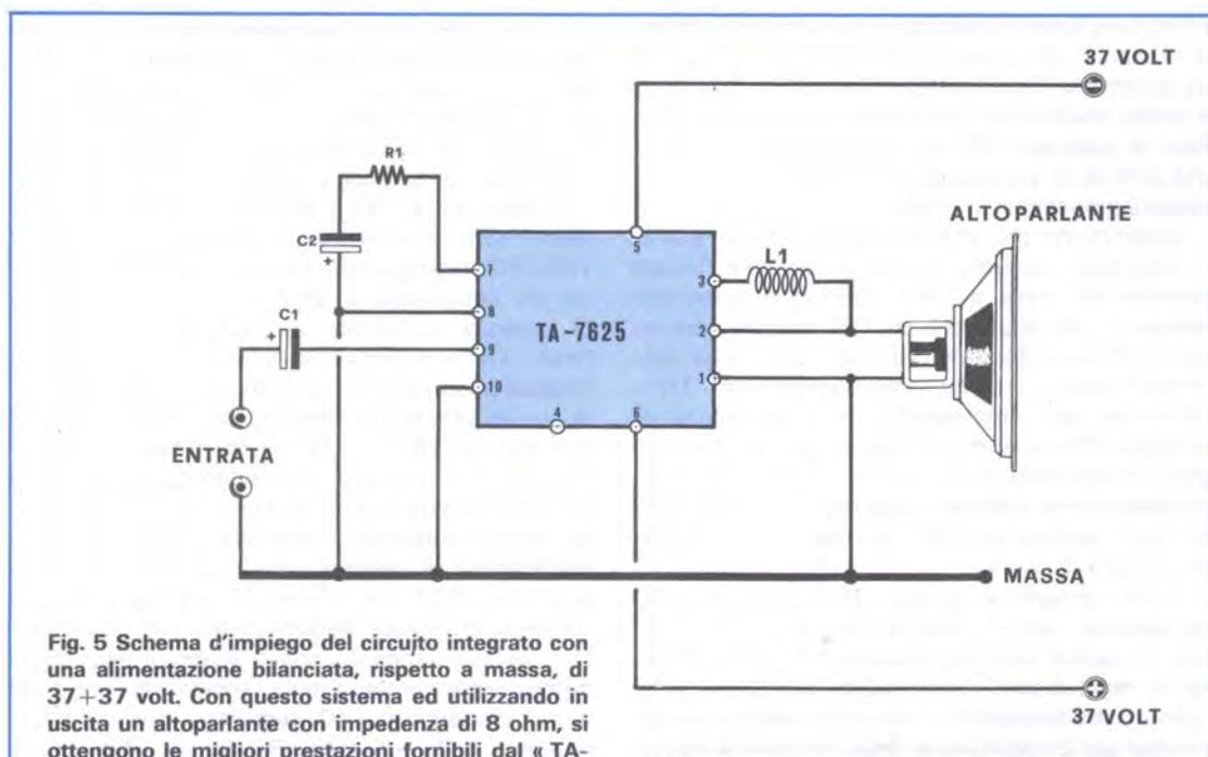
Fig. 5 Schema d'impiego del circuito integrato con una alimentazione bilanciata, rispetto a massa, di 37+37 volt. Con questo sistema ed utilizzando in uscita un altoparlante con impedenza di 8 ohm, si ottengono le migliori prestazioni fornibili dal « TA-7625 ». Da notare come la resistenza di carico sia esattamente di valore doppio rispetto al precedente tipo di alimentazione; un valore inferiore potrebbe provocare dannosi effetti.
