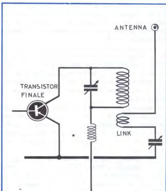
**Fig. 10** Se sul link è presente un condensatore di accordo, sarà sufficiente ruotarlo fino ad incontrare la posizione di massima tensione in uscita; se ciò si ottiene con il variabile alla massima capacità significa che il link ha poche spire, occorre, quindi, aumentare 1 o 2 a seconda del rendimento che si leggerà sul voltmetro.
