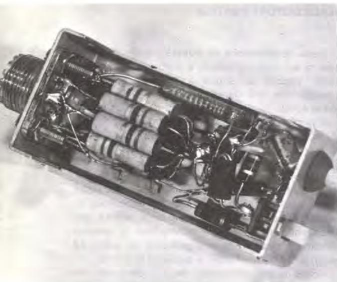
In fotografia appare l'interno di uno dei prototipi da noi montati. Si noti, in particolare, come vanno fissate le resistenze del carico. La saldatura dal « lato massa » può essere eseguita solo con un saldatore piuttosto grosso,, in caso contrario si potrà usare una paglietta di massa, oppure saldare le resistenze su di una calza di rame che verrà successivamente stretta attorno alla parte metallica di massa del connettore coassiale.
