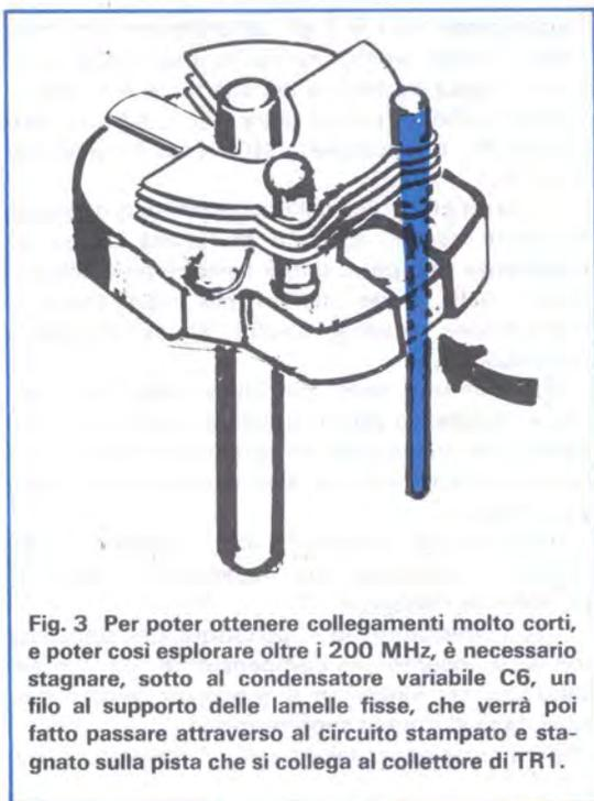
**Fig. 3** Per poter ottenere collegamenti molto corti, e poter così esplorare oltre i 200 MHz, è necessario stagnare, sotto al condensatore variabile C6, un filo al supporto delle lamelle fisse, che verrà poi fatto passare attraverso al circuito stampato e stagnato sulla pista che si collega al collettore di TR1.
