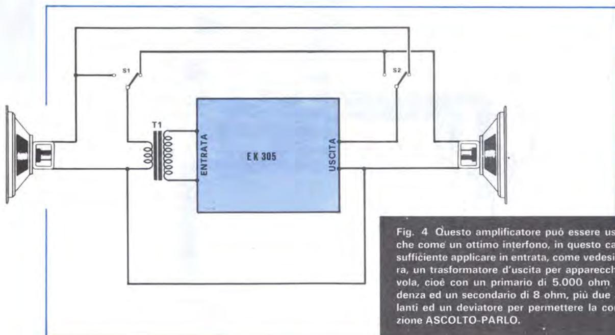
Fig. 4 Questo amplificatore può essere usato anche come un ottimo interfono, in questo caso sarà sufficiente applicare in entrata, come vedesi in figura, un trasformatore d'uscita per apparecchi a valvola, cioè con un primario di 5.000 ohm d'impedenza ed un secondario di 8 ohm, più due altoparlanti ed un deviatore per permettere la commutazione ASCOLTO-PARLO.
