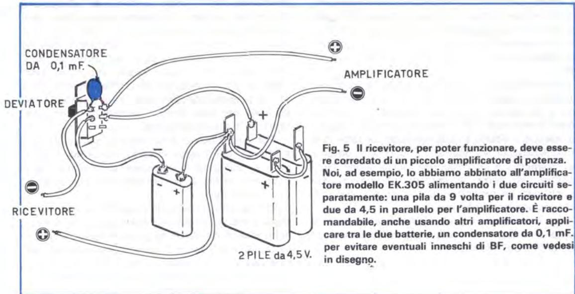
Fig. 5 Il ricevitore, per poter funzionare, deve essere corredato di un piccolo amplificatore di potenza. Noi, ad esempio, lo abbiamo abbinato all'amplificatore modello EK.305 alimentando i due circuiti separatamente: una pila da 9 volta per il ricevitore e due da 4,5 in parallelo per l'amplificatore. È raccomandabile, anche usando altri amplificatori, applicare tra le due batterie, un condensatore da 0,1 mF. per evitare eventuali inneschi di BF, come vedesi in disegno.
