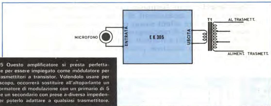
Fig. 5 Questo amplificatore si presta perfettamente per essere impiegato come modulatore per ricetrasmittitori a transistor. Volendolo usare per tale scopo, occorrerà sostituire all'altoparlante un trasformatore di modulazione con un primario di 5 ohm e un secondario con prese a diversa impedenza per poterlo adattare a qualsiasi trasmettitore.
