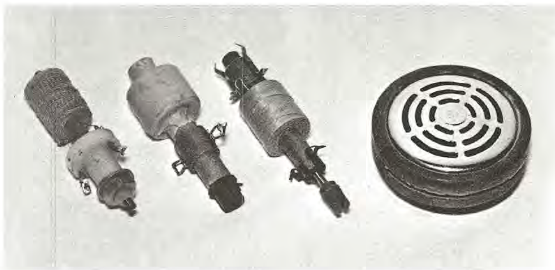
Fig. 4 In questa foto sono visibili tre tipi di bobine L.1 adatte al nostro circuito che troverete con facilità in ogni negozio radio. La prima bobina a sinistra, richiedeva per poterla fare oscillare sui 20.000 Hz., una capacità di 220.000 pF. per C2 e 33.000 pF per C3, le altre due invece 33.000 pF. per C2 e 4.700 pF. per C3. A destra vi presentiamo la capsula microfonica piezoelettrica Geloso impiegata per il generatore ed il ricevitore.
