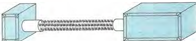
Fig. 5 Ricordatevi che applicando anteriormente ai due microfoni un tubo direzionale, è assolutamente indispensabile che questi risultino collocati esattamente sullo stesso asse, in caso contrario il ricevitore non riuscirebbe a captare il fascio degli ultrasuoni e quindi non si potrebbe ottenere i risultati cui ci siamo prefissi.
