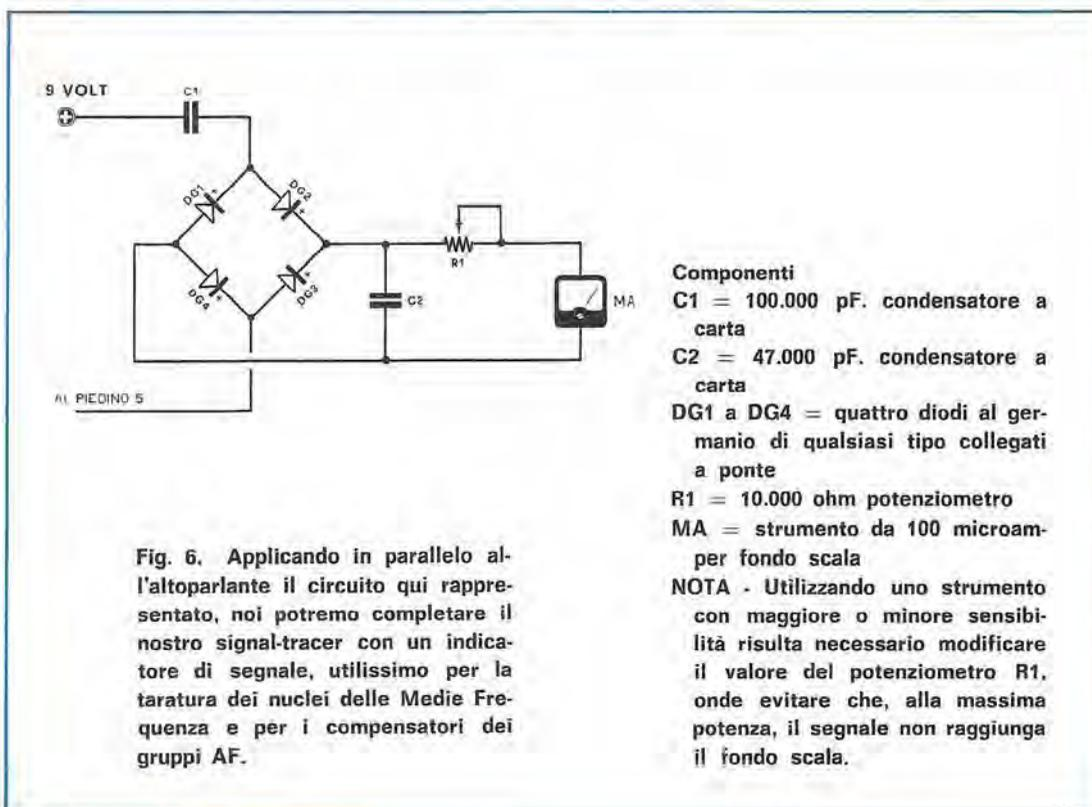
Fig. 6. Applicando in parallelo all'altoparlante il circuito qui rappresentato, noi potremo completare il nostro signal-tracer con un indicatore di segnale, utilissimo per la taratura dei nuclei delle Medie Frequenze e per i compensatori dei gruppi AF.
