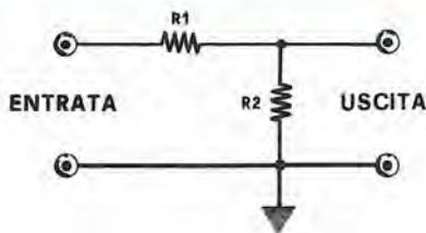
**Fig. 6.** Se il segnale da amplificare eroga una tensione superiore ai 20 millivolt, risulta indispensabile applicare in ingresso un filtro attenuatore costituito da due semplice resistenze. Questo filtro ha una risposta piatta, quindi non è consigliabile per i pick-up (vedi fig. 7).
