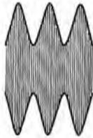
Fig. 14. Se moduliamo il segnale di AF con una frequenza di 1.000 Hz (prelevata da un oscillatore di BF applicato al posto del microfono) al 40-50%, noteremo che il segnale di AF aumenterà di ampiezza, confermandoci che la potenza irradiata subirà anch'essa un aumento. La potenza però si raddoppia soltanto nel caso che la modulazione riesca a raggiungere una percentuale del 100%.
