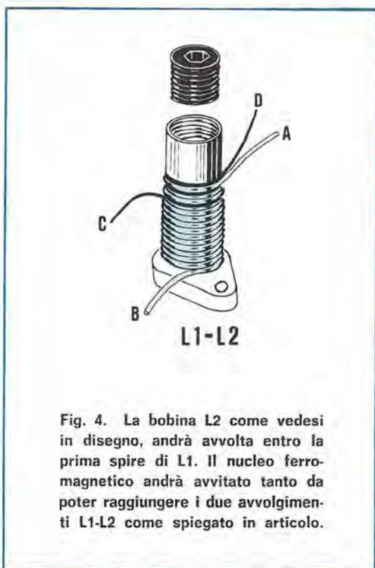
Fig. 4. La bobina L2 come vedesi in disegno, andrà avvolta entro la prima spire di L1. Il nucleo ferromagnetico andrà avvitato tanto da poter raggiungere i due avvolgimenti L1-L2 come spiegato in articolo.
