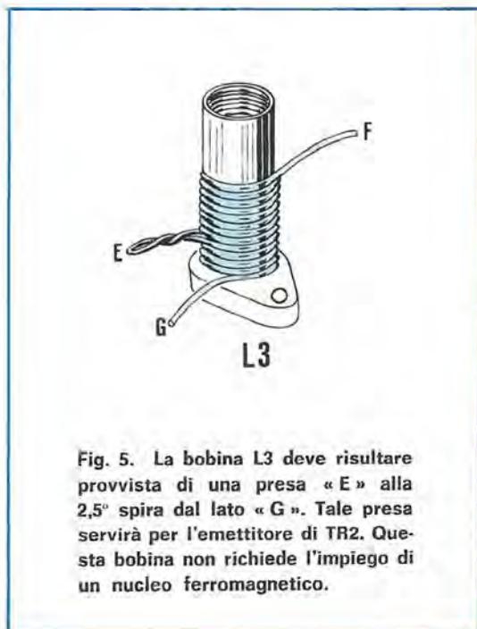
Fig. 5. La bobina L3 deve risultare provvista di una presa « E » alla 2,5° spira dal lato « G ». Tale presa servirà per l'emettitore di TR2. Questa bobina non richiede l'impiego di un nucleo ferromagnetico.
