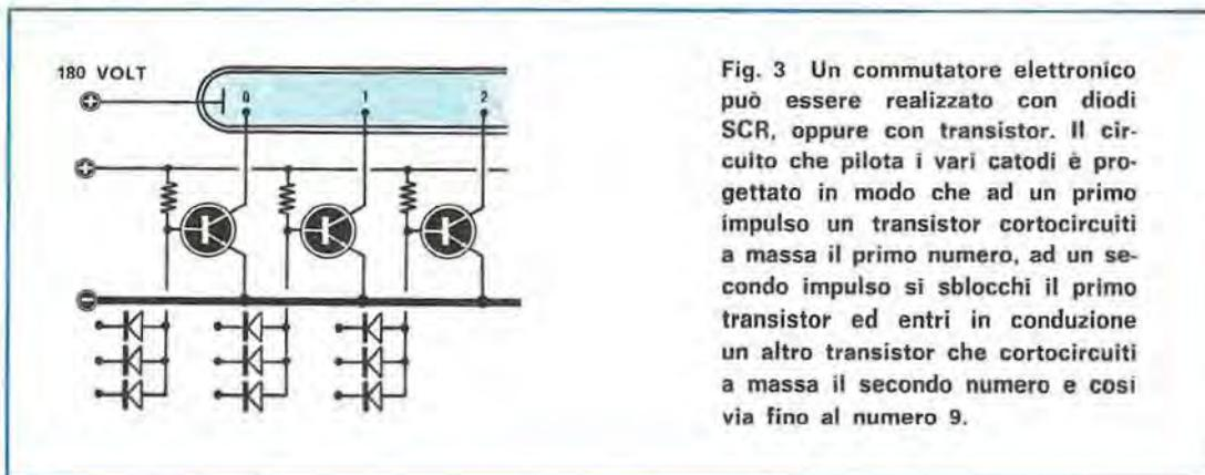
Fig. 3 Un commutatore elettronico può essere realizzato con diodi SCR, oppure con transistor. Il circuito che pilota i vari catodi è progettato in modo che ad un primo impulso un transistor cortocircuiti a massa il primo numero, ad un secondo impulso si sblocchi il primo transistor ed entri in conduzione un altro transistor che cortocircuiti a massa il secondo numero e così via fino al numero 9.
