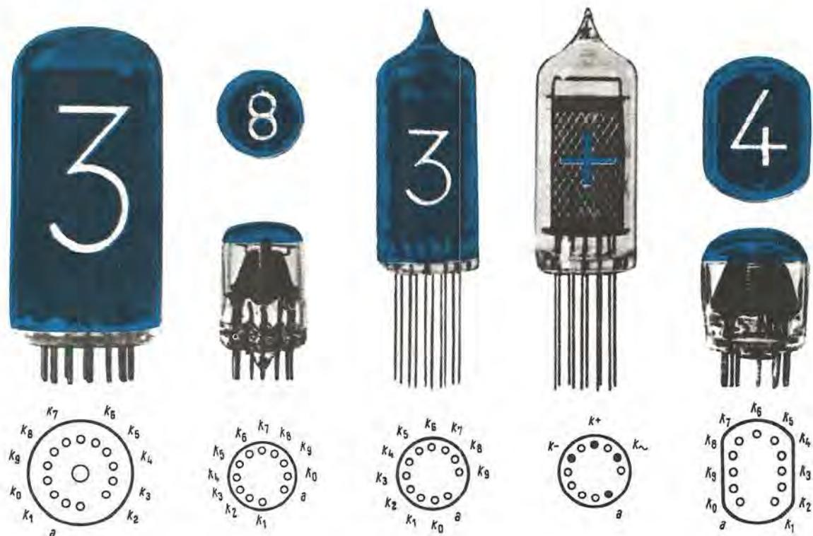
Dimensioni al naturale delle valvole nixie più facilmente reperibili in commercio e relative connessioni allo zoccolo. Precisiamo che per terminale « a » s'intende l'anodo, quindi a questo va applicata la tensione positiva dei 160 - 180 volt, mentre per K0 - K1 - K2 etc. s'intendono i catodi corrispondenti al numero che apparirà quando questo risulta collegato alla massa o al decodificatore.
