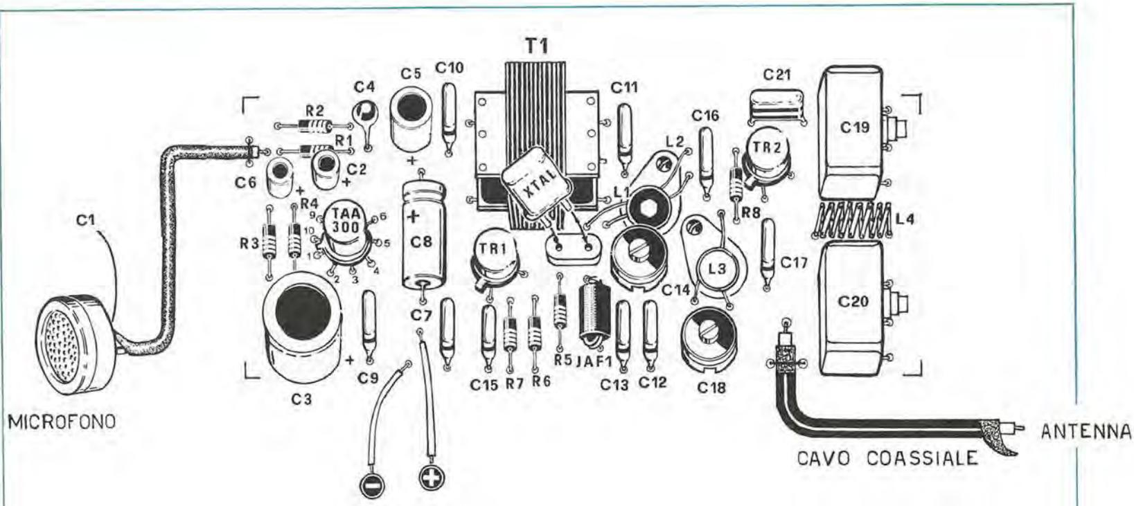
Fig. 3. Disposizioni dei componenti sul circuito stampato. Ricordiamo al lettore che la bobina L4 sarà avvolta a spire unite e che il condensatore C1 andrà collegato direttamente sui due terminali del microfono. Per l'uscita AF occorre necessariamente impiegare del cavo coassiale TV da 75 o 52 ohm. A destra la disposizione dei terminali dell'integrato TAA.300 e dei transistor 2N1711.
