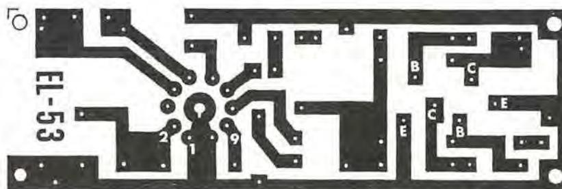
Fig. 5. In basso vi presentiamo la disposizione dei componenti sul circuito stampato. Nel montaggio occorre fare attenzione ai terminali dell'integrato TAA.300, visibili in fig. 7.
