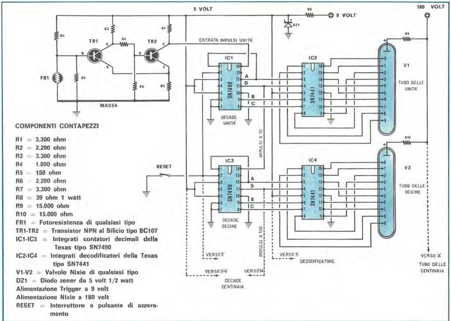
la tensione fosse inferiore, occorrerà ridurre il valore di R1, se superiore, aumentarlo.
