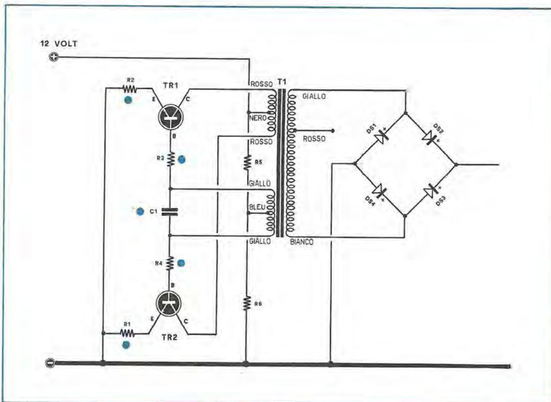
tualmente invertendoli, una volta sulla base di TR1 ed un'altra su TR2) fino a trovare la posizione idonea, quella in cui il trasformatore emetterà una vibrazione ben udibile, sui 250-300 Hz.
