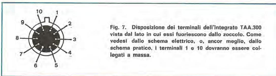
**Fig. 7.** Disposizione dei terminali dell'integrato TAA.300 vista dal lato in cui essi fuoriescono dallo zoccolo. Come vedesi dallo schema elettrico, o, ancor meglio, dallo schema pratico, i terminali 1 e 10 dovranno essere collegati a massa.
