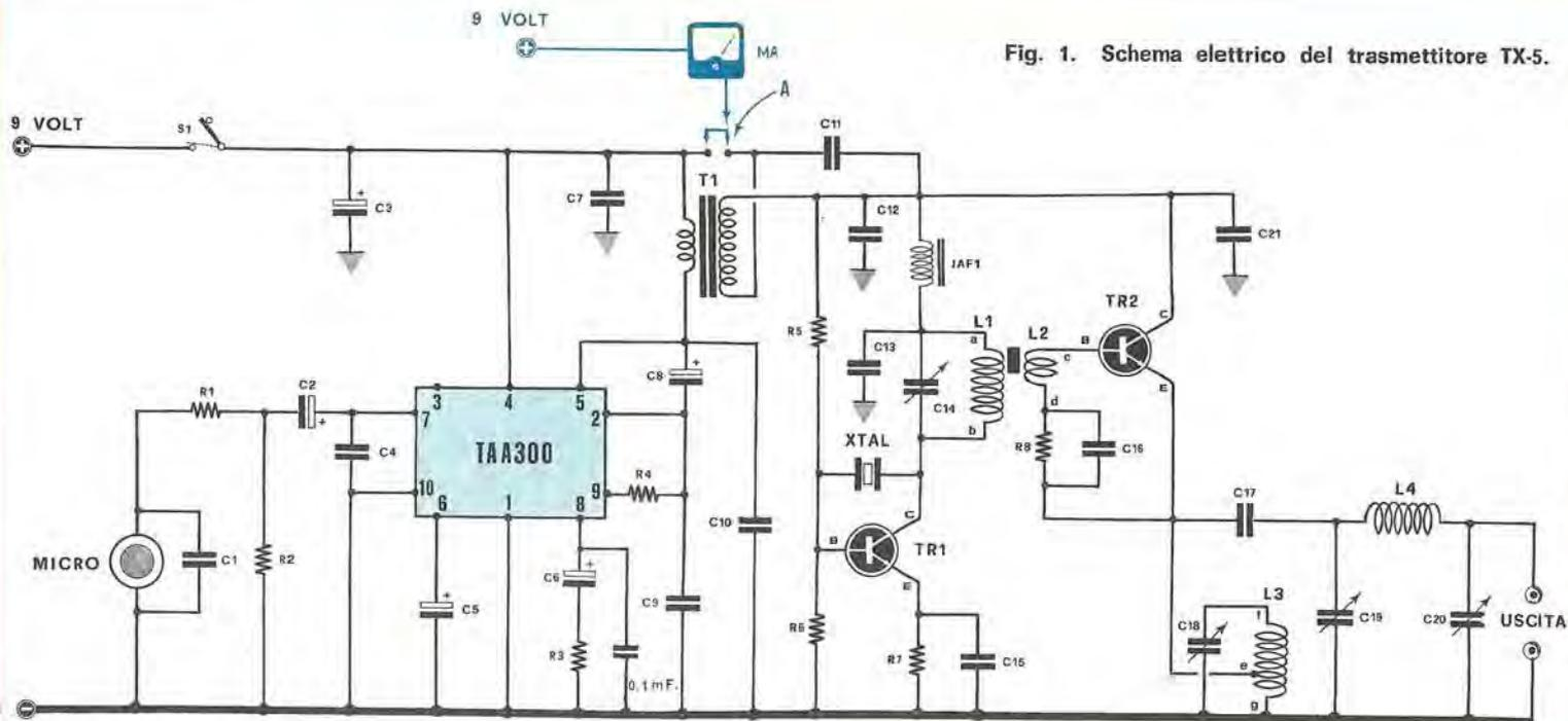
Fig. 1. Schema elettrico del trasmettitore TX-5.
