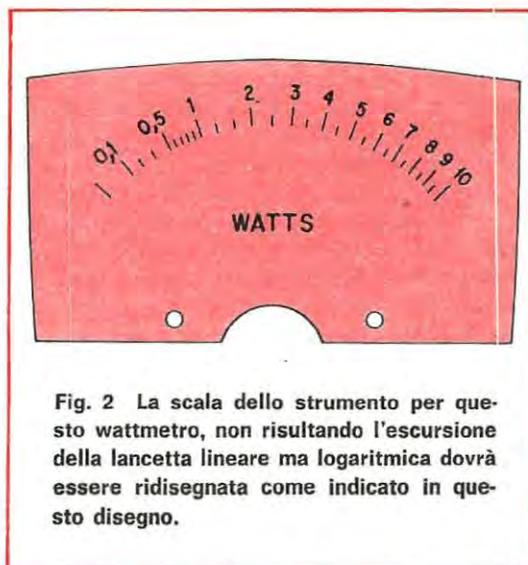
Fig. 2 La scala dello strumento per questo wattmetro, non risultando l'escursione della lancetta lineare ma logaritmica dovrà essere ridisegnata come indicato in questo disegno.
