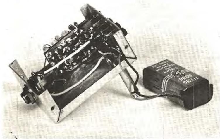
**In questa foto il prototipo del distorsore per chitarra da noi montato per le prove di collaudo.**
