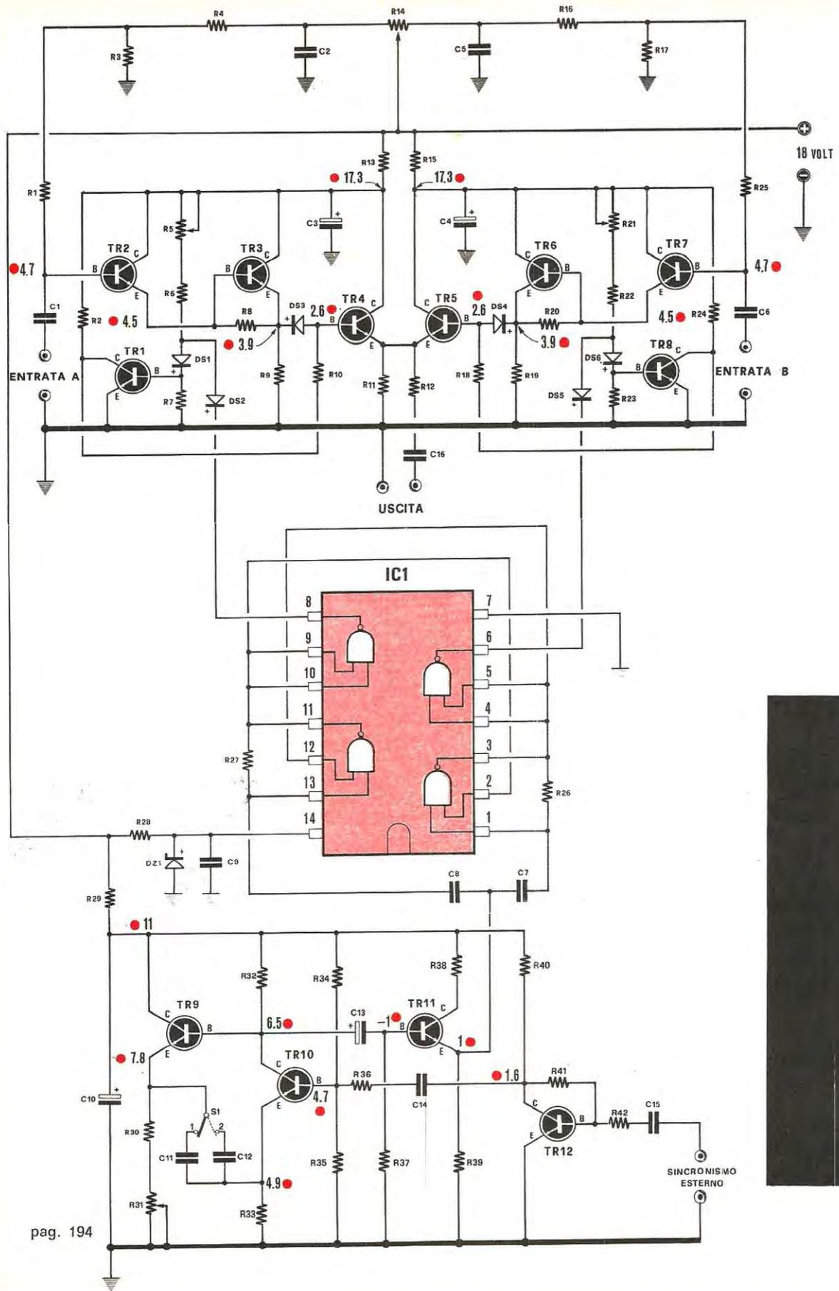
di TR10, tramite il condensatore C13, e applicate alla base di TR11 per amplificarle ed applicarle ai due condensatori C8 e C7 che comandano il bistabile, formato da due nand inclusi nell'integrato SN7400.
