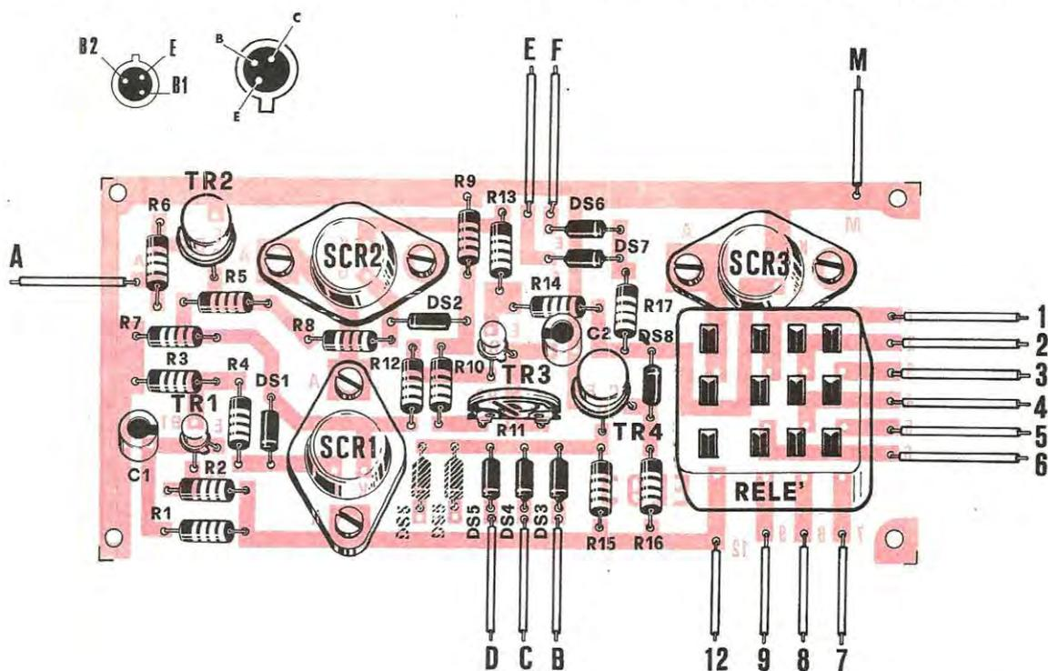
Fig. 3 Disposizione dei componenti sul circuito stampato. In alto disposizione dei terminali dei transistor unigiunzione e dei 2N1711. Nel disegno i diodi tratteggiati indicati con la sigla DS5 si potranno inserire soltanto se si desidera ampliare le prese che comandano la base di TR4. Il relè andrà inserito nell'apposito zoccolo montato sul circuito.
