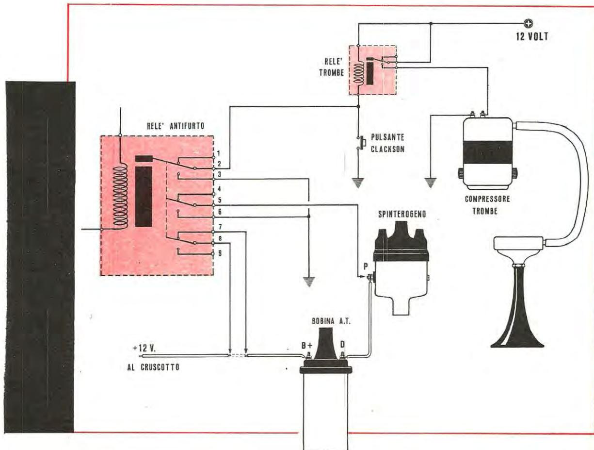
si vede dal disegno di fig. 5. Le prese dei terminali del relè verranno utilizzate: una (terminali 2-3) per alimentare il relè delle trombe o del clacson; una (terminali 5-6) verrà collegata alla presa delle puntine dello spinterogeno; e l'altra (terminali 7-8) in serie all'alimentazione della bobina AT, oppure all'alimentazione dell'accensione elettronica, (se siete uno dei nostri lettori, certamente l'avrete già installata).
