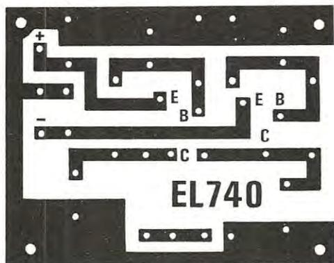
Fig. 11 Circuito stampato a grandezza naturale dell'alimentatore ad uscita differenziata.
