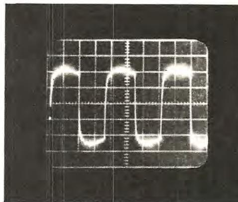
**Fig. 7** Se la forma d'onda ottenuta in uscita, anziché risultare sinusoidale, si presenta quadra come in questa foto e ruotando R1 non si riesce a modificarla, occorrerà ridurre R8 a 180-150 ohm oppure sostituire LP1.
