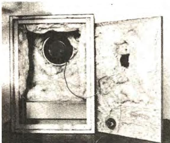
Tutto l'interno del mobile, come vedesi in questa foto, andrà rivestito con dell'ovatta o altro materiale fonoassorbente. Solo la parte inferiore del mobile, quello relativo al condotto acustico, compreso la porzione posteriore del coperchio, nè dovrà risultare sprovvisto.
