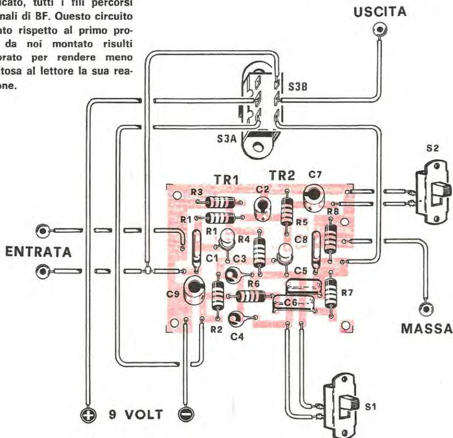
stenza R8, sui terminali di uscita è stato inserito per attenuare tutte le frequenze superiori ai 4.000-5.000 Hertz che, se troppo accentuate potrebbero produrre suoni alquanto sgradevoli.
