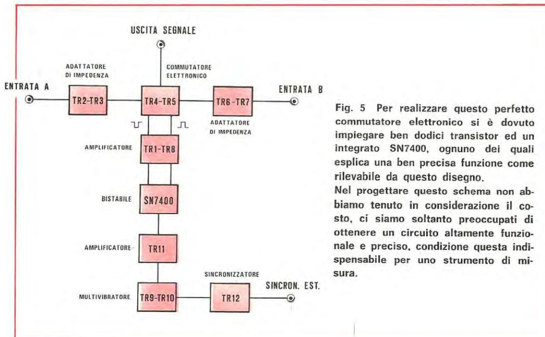
Fig. 5 Per realizzare questo perfetto commutatore elettronico si è dovuto impiegare ben dodici transistor ed un integrato SN7400, ognuno dei quali esplica una ben precisa funzione come rilevabile da questo disegno. Nel progettare questo schema non abbiamo tenuto in considerazione il costo, ci siamo soltanto preoccupati di ottenere un circuito altamente funzionale e preciso, condizione questa indispensabile per uno strumento di misura.
