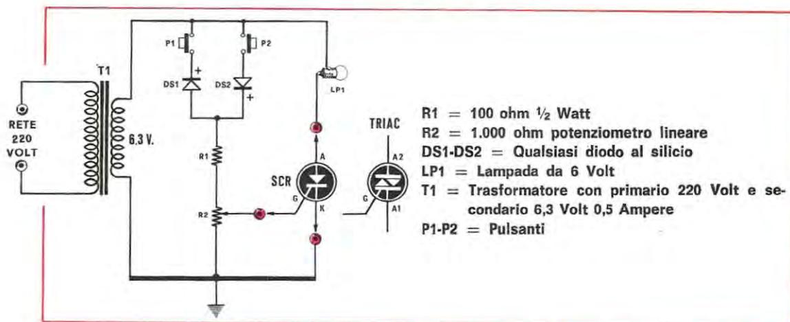
In queste condizioni al gate del diodo controllato sono inviate solo semionde negative, e quindi esso lascia passare attraverso LP1 solo le semionde negative della tensione di alimentazione.
