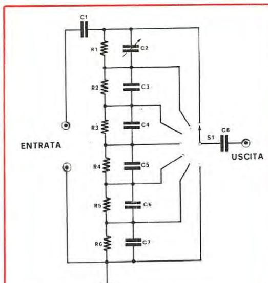
Fig. 9 Attenuatore compensato
