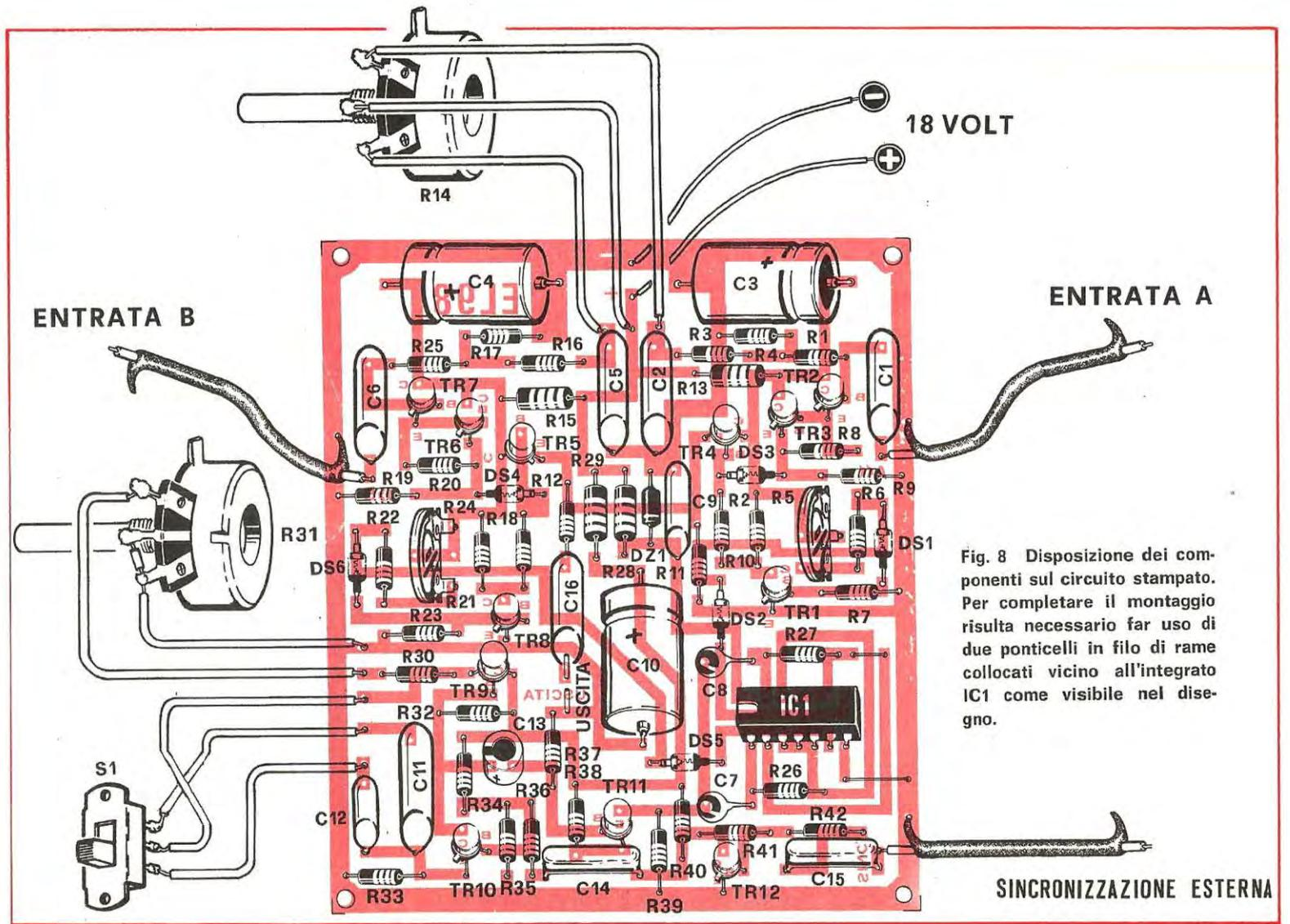
Fig. 8 Disposizione dei componenti sul circuito stampato. Per completare il montaggio risulta necessario far uso di due ponticelli in filo di rame collocati vicino all'integrato IC1 come visibile nel disegno.
