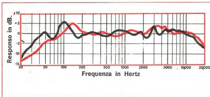
**Fig. 1** Il rendimento acustico di questa cassa sulle frequenze piú basse, anche impiegando altoparlante comuni a basso prezzo, risulta notevolmente rafforzato. Le due righe nera e rossa rappresentano il rendimento acustico di due diversi tipi di altoparlanti del diametro di 180 mm. cadauno.
