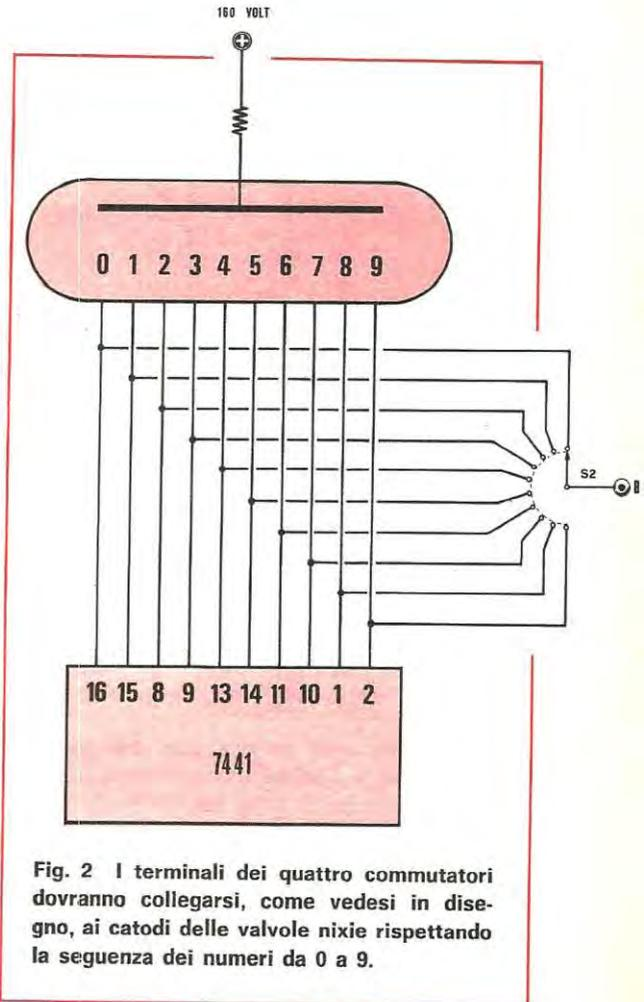
Fig. 2 I terminali dei quattro commutatori dovranno collegarsi, come vedesi in disegno, ai catodi delle valvole nixie rispettando la sequenza dei numeri da 0 a 9.
