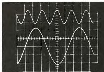
**Fig. 11** Con l'aiuto dell'attenuatore applicato sulle due entrate, noi potremo far apparire sullo schermo due forme d'onda di ampiezza diversa.
