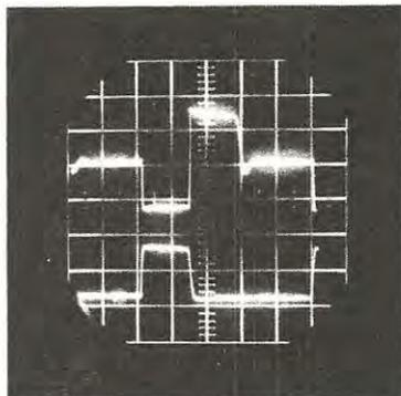
Con questo commutatore elettronico avrete la possibilità di controllare con un normale oscilloscopio due segnali contemporaneamente.
