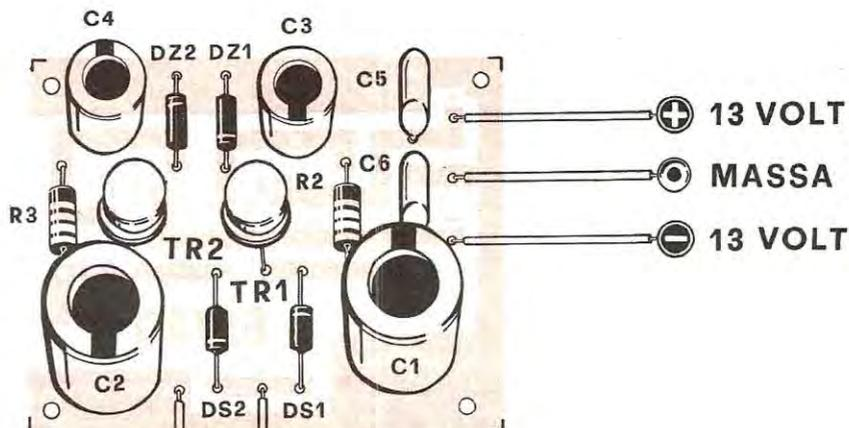
Fig. 12 Disposizione dei componenti sul circuito stampato dell'alimentatore.
