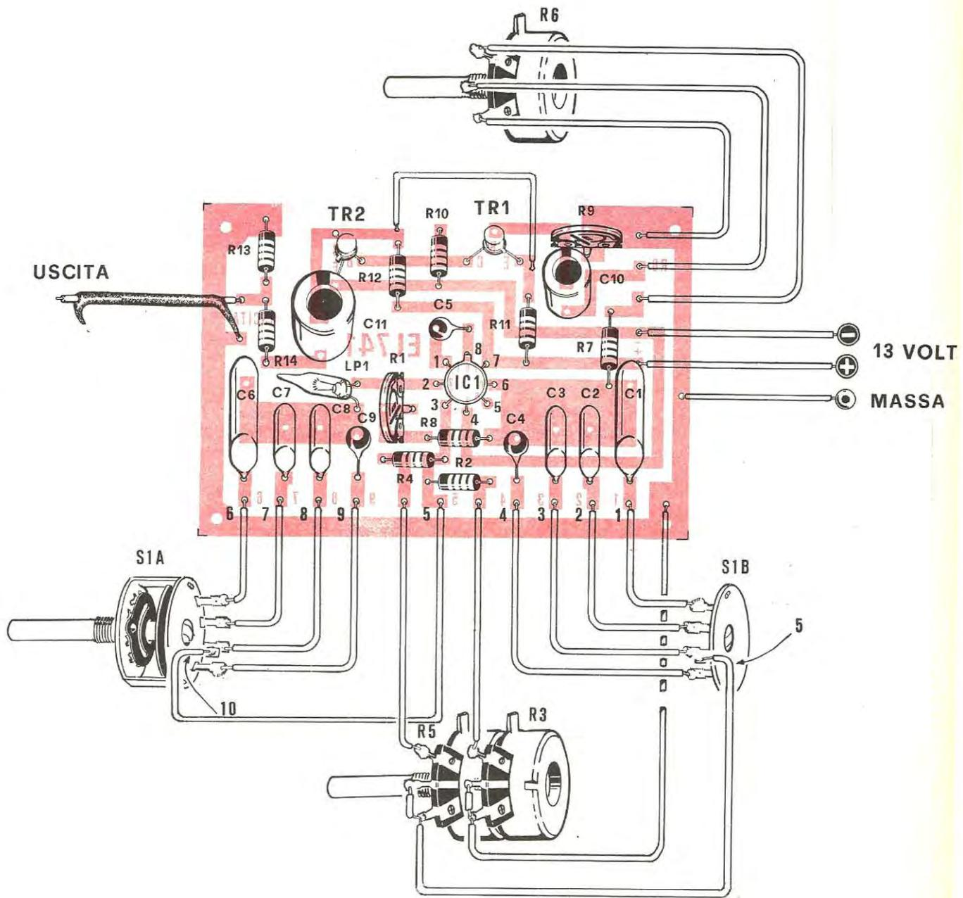
Fig. 5 Disposizione dei componenti sul circuito stampato. Per rendere lo schema piú comprensibile, il doppio commutatore S1A - S1B è stato disegnato con le due sezioni separate anche se in pratica questo risulta un unico commutatore a 2 vie 4 posizioni. Raccomandiamo al lettore di non utilizzare per LP1 lampadine con caratteristiche notevolmente diverse da quelle da noi indicate, se si desidera ottenere uno strumento preciso e stabile.
