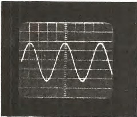
**Fig. 6** Ruotando il trimmer R1 nella posizione richiesta l'onda in uscita risulterà perfettamente sinusoidale come visibile in questa foto. Diversamente le forme d'onda ottenute potranno risultare analoghe a quelle indicate in fig. 7 e 8.
