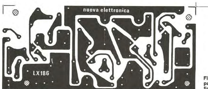
Fig. 8 Circuito stampato del preamplificatore.
