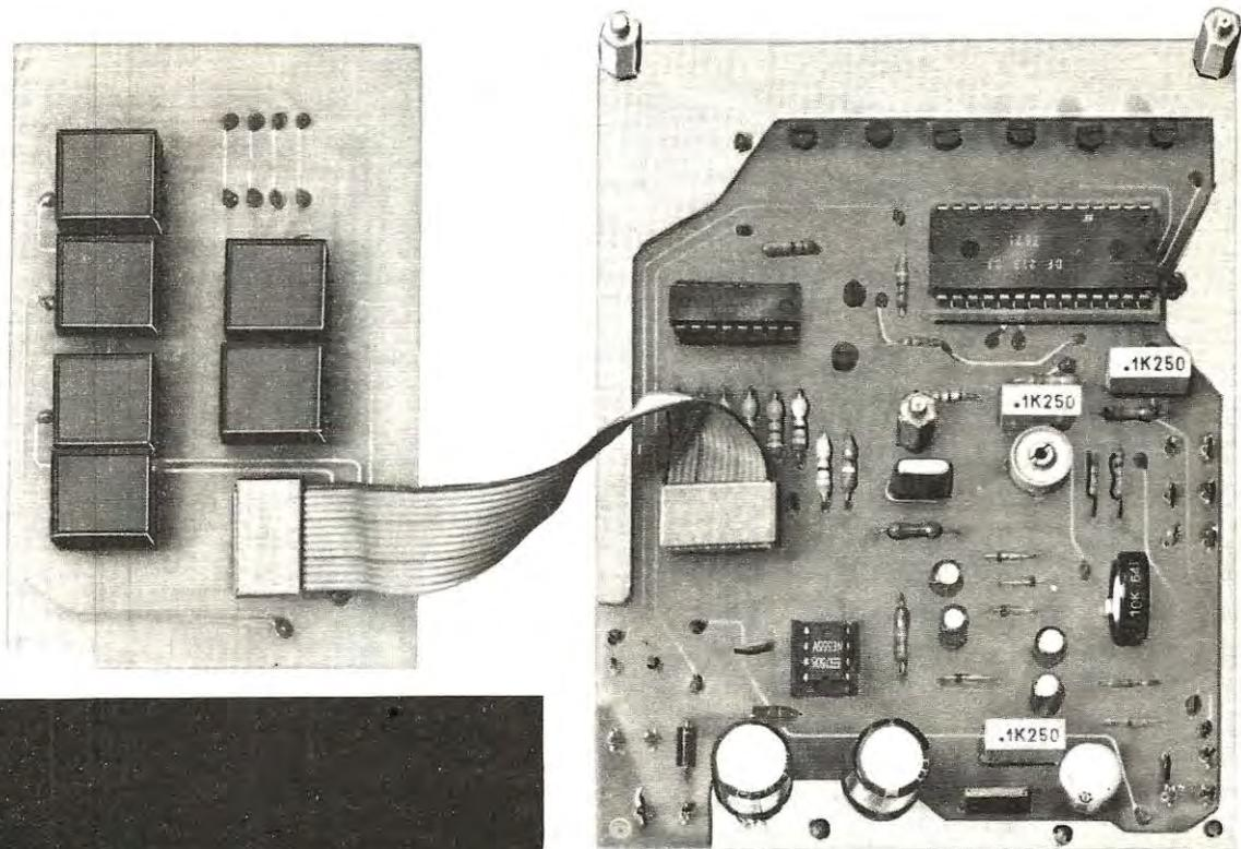
Nella foto i due telai che compongono il nostro cronometro visti separati per far vedere i componenti posti nel circuito sottostante. Si noti la piattina flessibile che congiunge i due circuiti.
