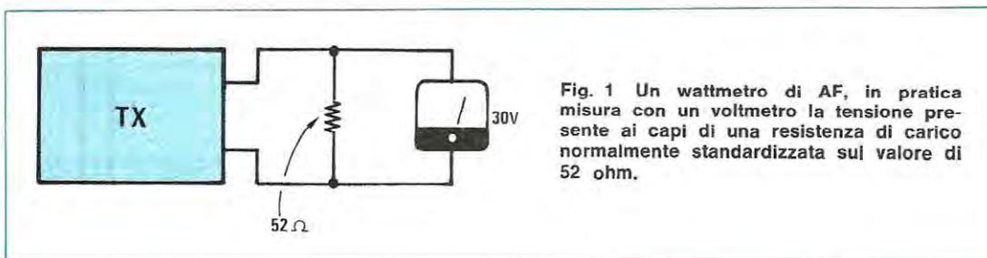
Fig. 1 Un wattmetro di AF, in pratica misura con un voltmetro la tensione presente ai capi di una resistenza di carico normalmente standardizzata sul valore di 52 ohm.
