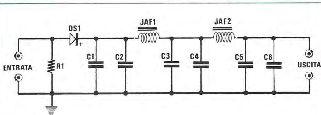
Fig. 11 Schema elettrico della sonda di potenza.
