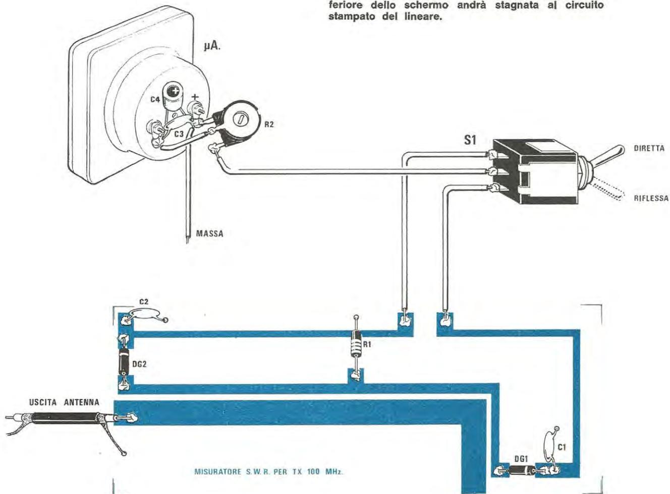
di non si hanno ritorni di AF e la lancetta dello strumento, in posizione ONDA RIFLESSA, si porterà sullo ZERO.
