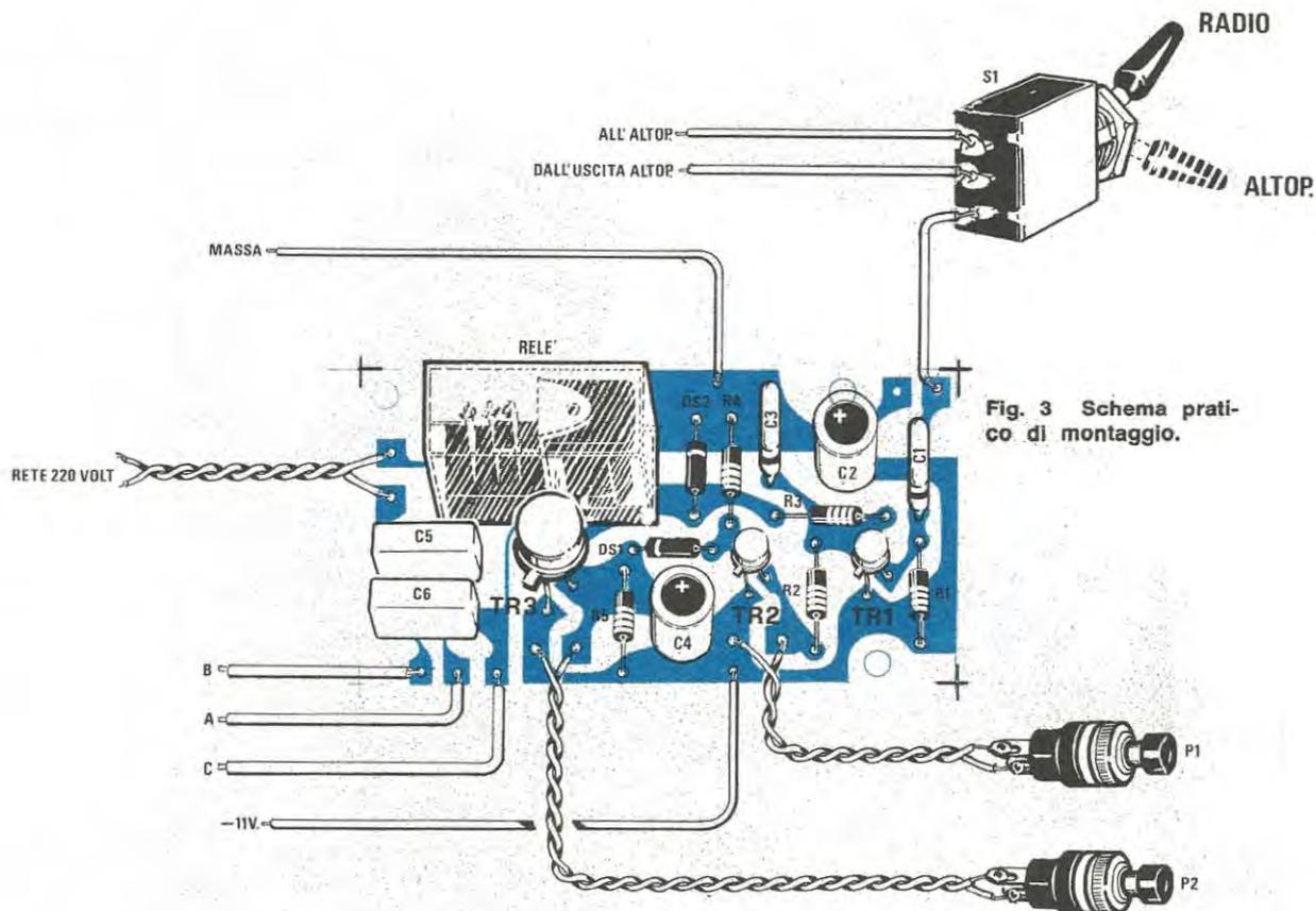
Fig. 3 Schema pratico di montaggio.
