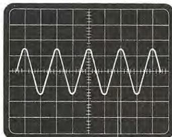
**Fig. 6** Ottenuta l'onda sinusoidale, ruotate ora il trimmer R26 in modo da ridurre l'ampiezza del segnale. Cioè da 5 quadretti, la dovremo restringere a circa 3,3 quadretti. Dovremo cioè ottenere un segnale con una ampiezza massima di 1 volt picco-picco.
