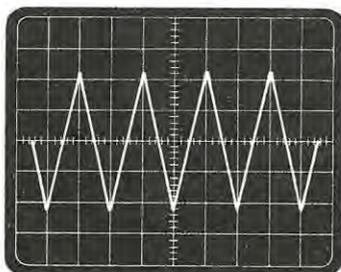
**Fig. 5** Se ruotate oltre al necessario il trimmer R23, constaterete che l'onda da quasi sinusoidale si trasformerà in una perfetta onda triangolare, contemporaneamente da 5 quadretti si abbasserà a 4,5 quadretti come vedesi in figura.
