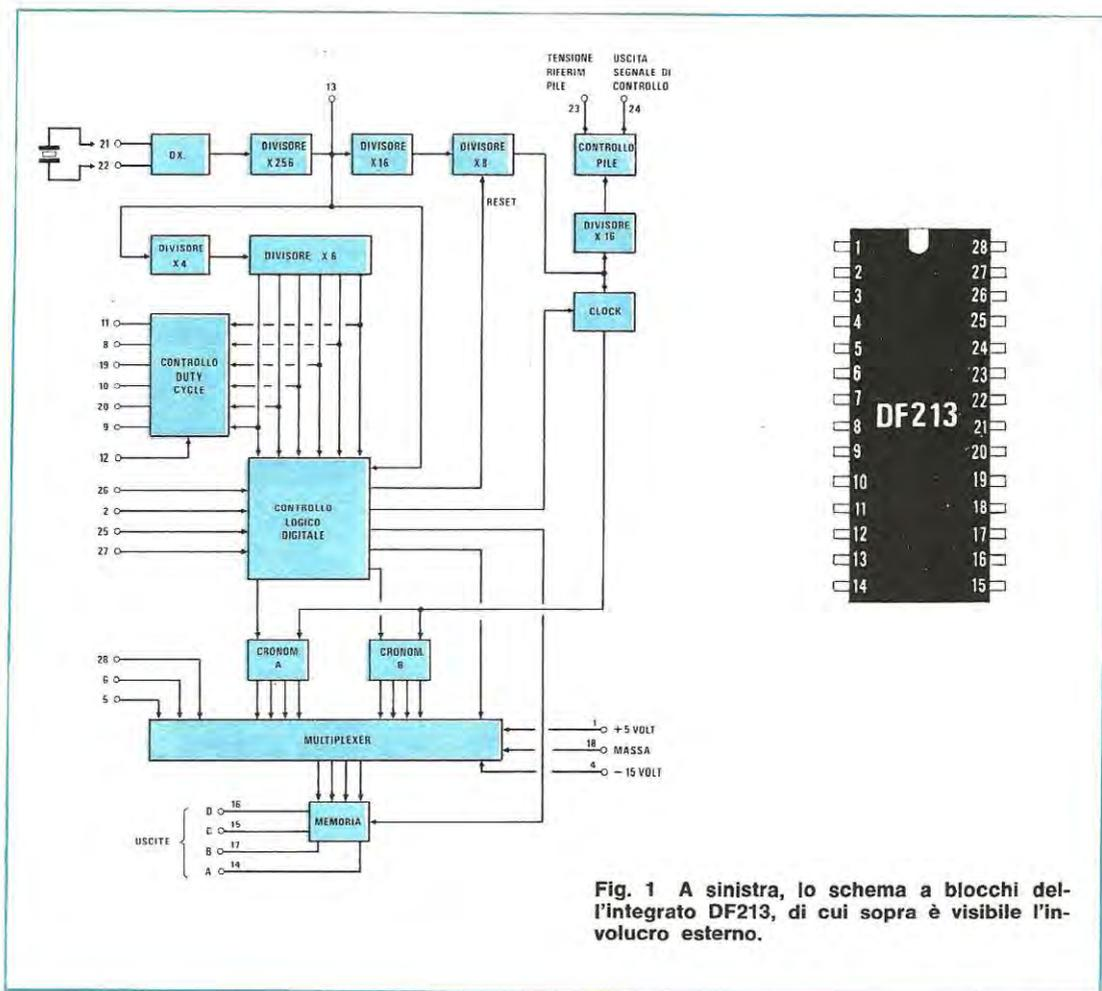
Fig. 1 A sinistra, lo schema a blocchi dell'integrato DF213, di cui sopra è visibile l'involucro esterno.
