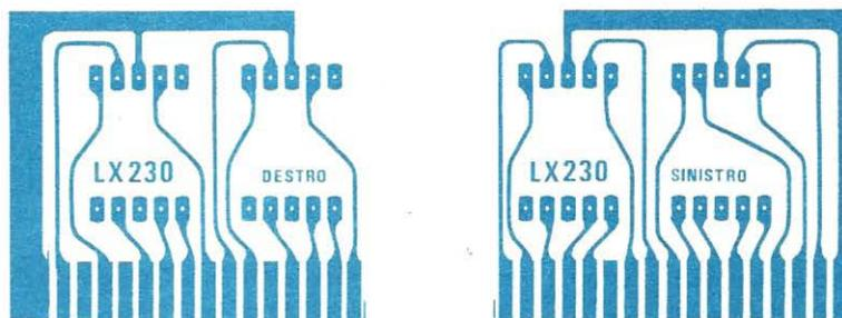
Fig. 4 I due circuiti stampati necessari per ricevere i quattro display del contagiri.
