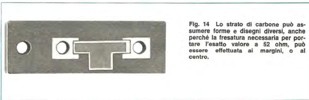
**Fig. 14** Lo strato di carbone può assumere forme e disegni diversi, anche perché la fresatura necessaria per portare l'esatto valore a 52 ohm, può essere effettuata ai margini, o al centro.
