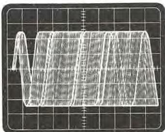
Fig. 13 Se applichiamo in ingresso un segnale di ampiezza superiore ai 100 millivolt, o ruotiamo al massimo R11, constateremo che l'espansione aumenta, il che significa che superiamo i 75 KHz di deviazione. Tale eccedenza verrà segnalata anche dallo strumento indicatore inserito nel circuito.
