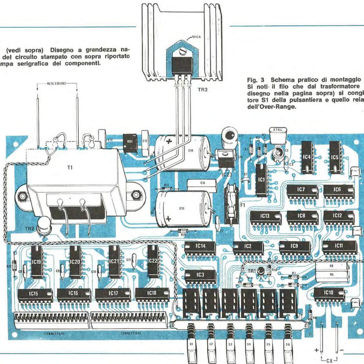
Fig. 3 Schema pratico di montaggio del capacimetro. Si noti il filo che dal trasformatore T1 (vedi pure il disegno nella pagina sopra) si congiunge all'interruttore S1 della pulsantiera e quello relativo al diodo led dell'Over-Range.
