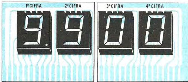
Fig. 5 Sui due circuiti LX230 monteremo i quattro display tenendo la parte zigrinata rivolta verso l'alto.
