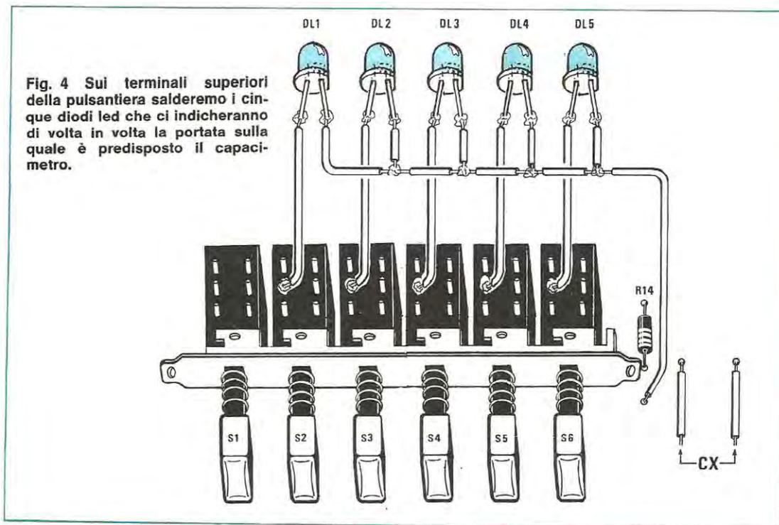
Fig. 4 Sui terminali superiori della pulsantiera salderemo i cinque diodi led che ci indicheranno di volta in volta la portata sulla quale è predisposto il capacimetro.
