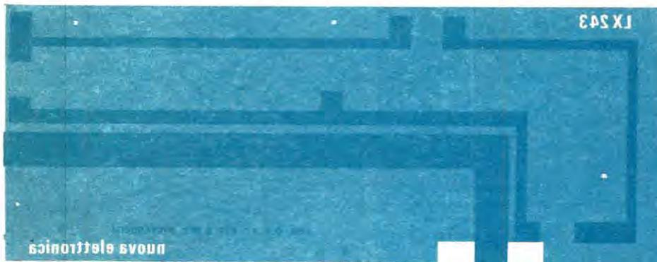
**Fig. 2** Disegno a grandezza naturale del circuito stampato a doppia faccia del misuratore di SWR. Tale circuito è idoneo anche a lavorare sui 145 MHz, come pure dicasi per il lineare da 10-12 watt modello LX.242.
