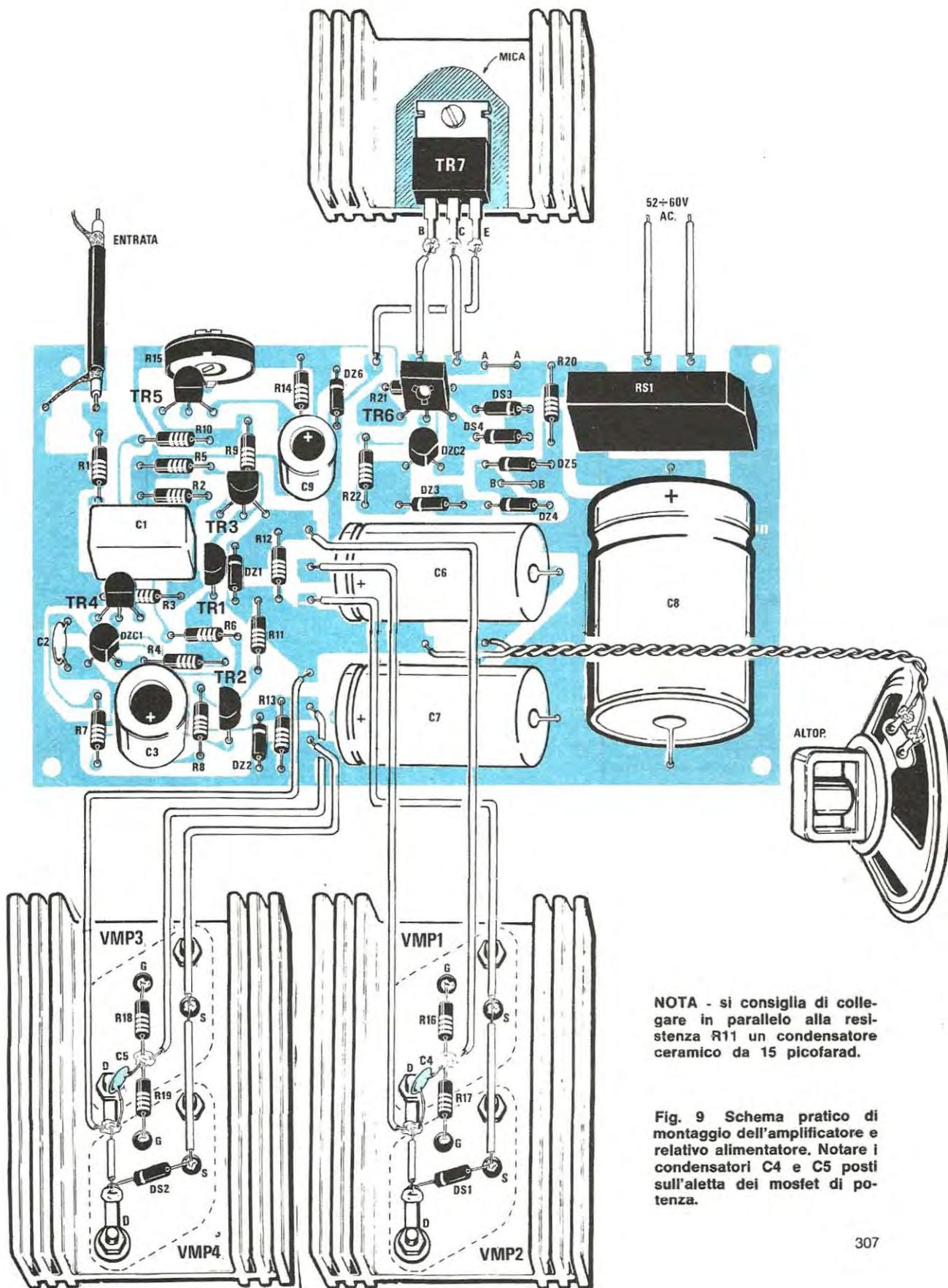
NOTA - si consiglia di collegare in parallelo alla resistenza R11 un condensatore ceramico da 15 picofarad.
