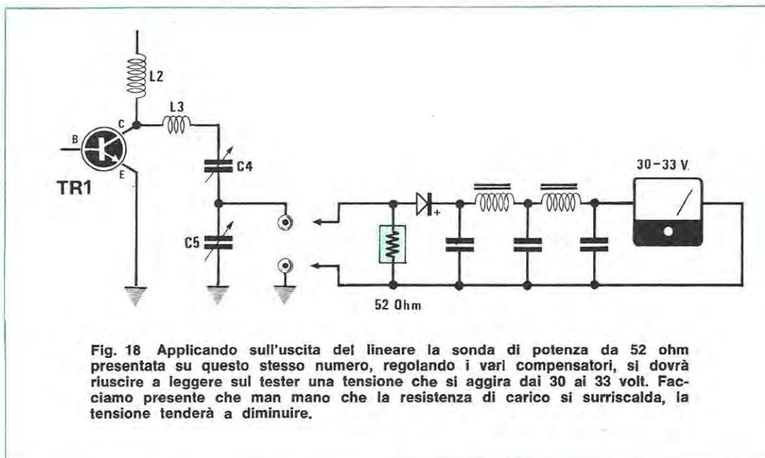
Fig. 18 Applicando sull'uscita del lineare la sonda di potenza da 52 ohm presentata su questo stesso numero, regolando i vari compensatori, si dovrà riuscire a leggere sul tester una tensione che si aggira dai 30 ai 33 volt. Facciamo presente che man mano che la resistenza di carico si surriscalda, la tensione tenderà a diminuire.
