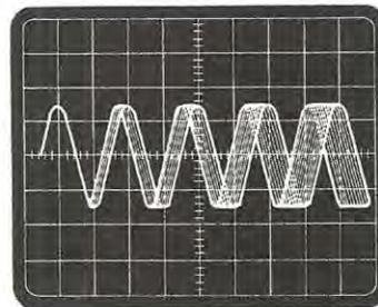
**Fig. 9** Se il segnale di BF anziché risultare da 100 millivolt, ha un'ampiezza inferiore, anche la deviazione in frequenza proporzionalmente si riduce. Nella foto un segnale modulato in FM con una deviazione massima di 35 KHz.
