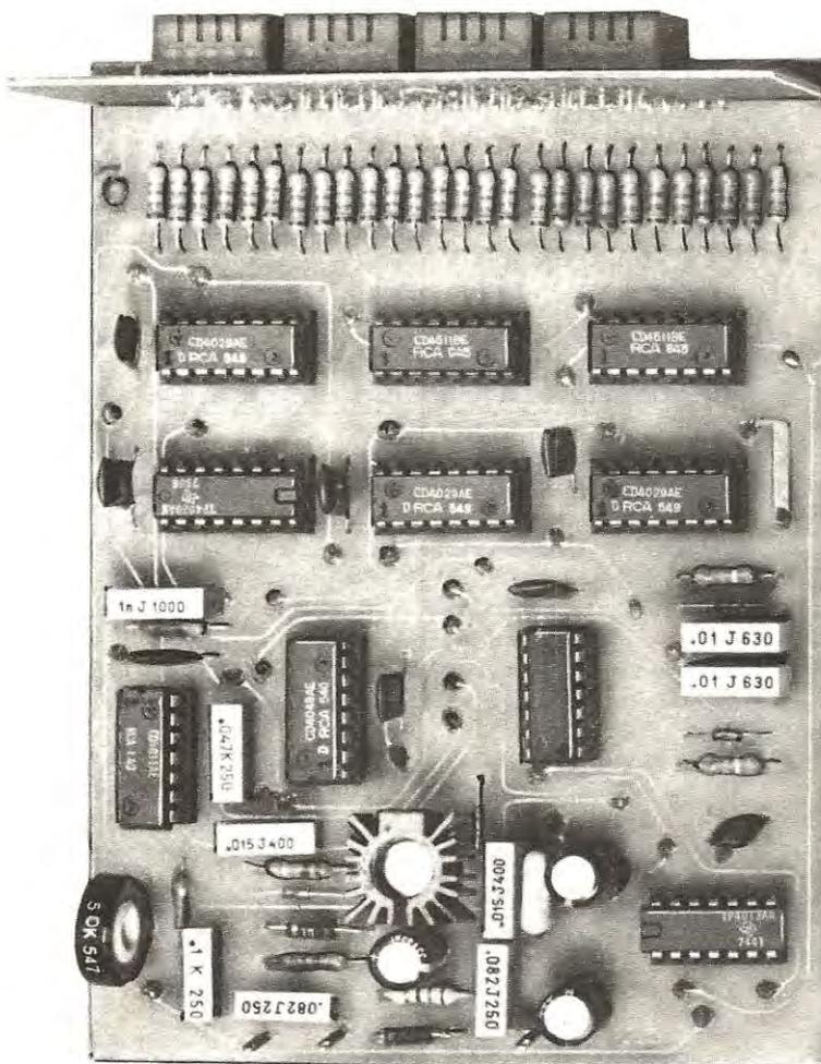
Naturalmente sarà necessario interporre fra le decodifiche e i display delle «memorie» in modo che i numeri sui display stessi vengano visualizzati solo alla fine di ogni ciclo di lettura e vi restino per tutto il ciclo successivo, altrimenti si vedranno i numeri correre in continuità.
