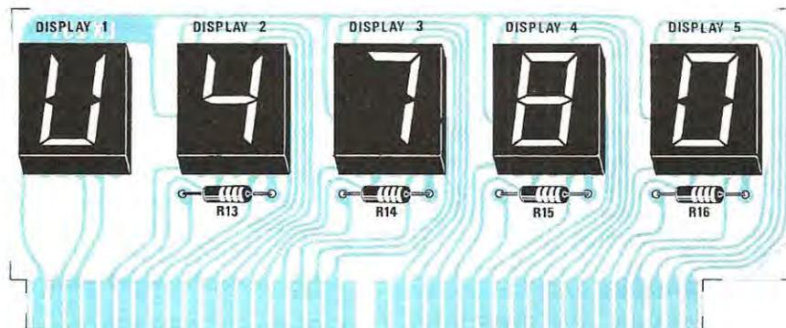
**Fig. 5** Realizzazione pratica del telaio relativo ai display FND.500. Se non interessa far apparire i punti decimali sui display è sufficiente non inserire le resistenze poste sotto ad essi come leggesi nell'articolo.
