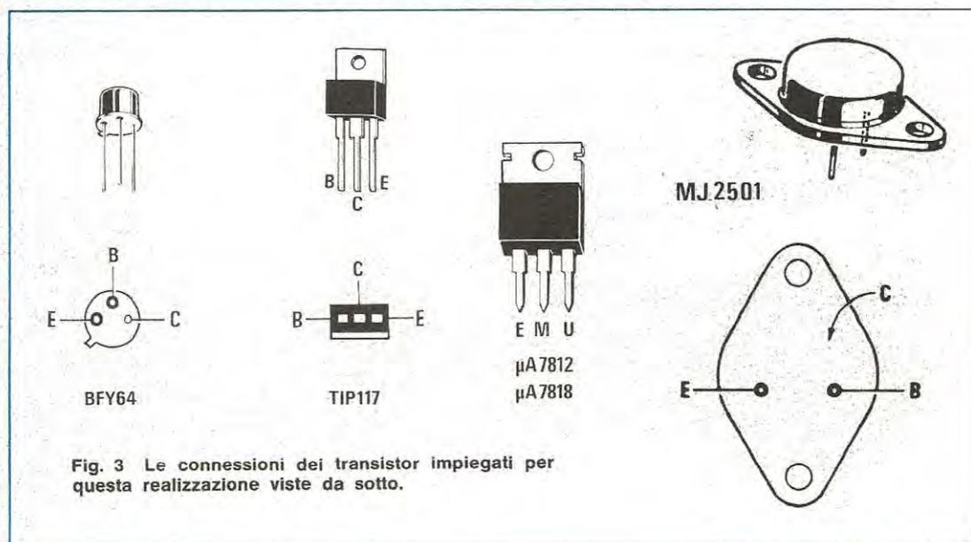
Fig. 3 Le connessioni dei transistor impiegati per questa realizzazione viste da sotto.
