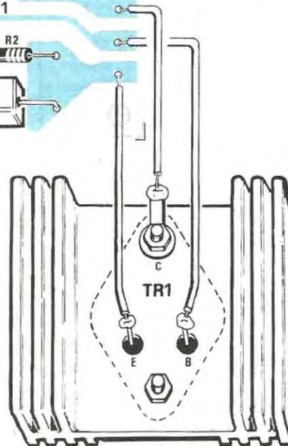
Fig. 4 Schema pratico di montaggio dell'alimentatore da 18 volt, 3 ampère. Nota: il darlington TR1 va isolato con una mica e relative rondelle dall'aletta di raffreddamento.
