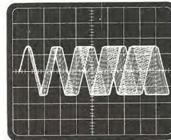
**Fig. 8** Applicando in ingresso al compressore un segnale di BF da 100 millivolt, vedrete le cinque sinusoidi espandersi. Quando la 5<sup>a</sup> sinusoidi toccherà la 4<sup>a</sup> voi modulerete in FM con una deviazione di circa 75 KHz.
