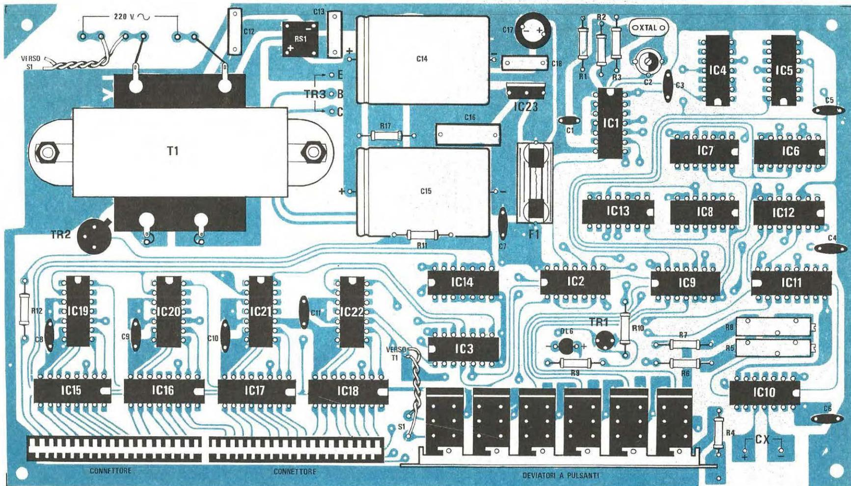
Fig. 2 (vedi sopra) Disegno a grandezza naturale del circuito stampato con sopra riportata la stampa serigrafica dei componenti.
