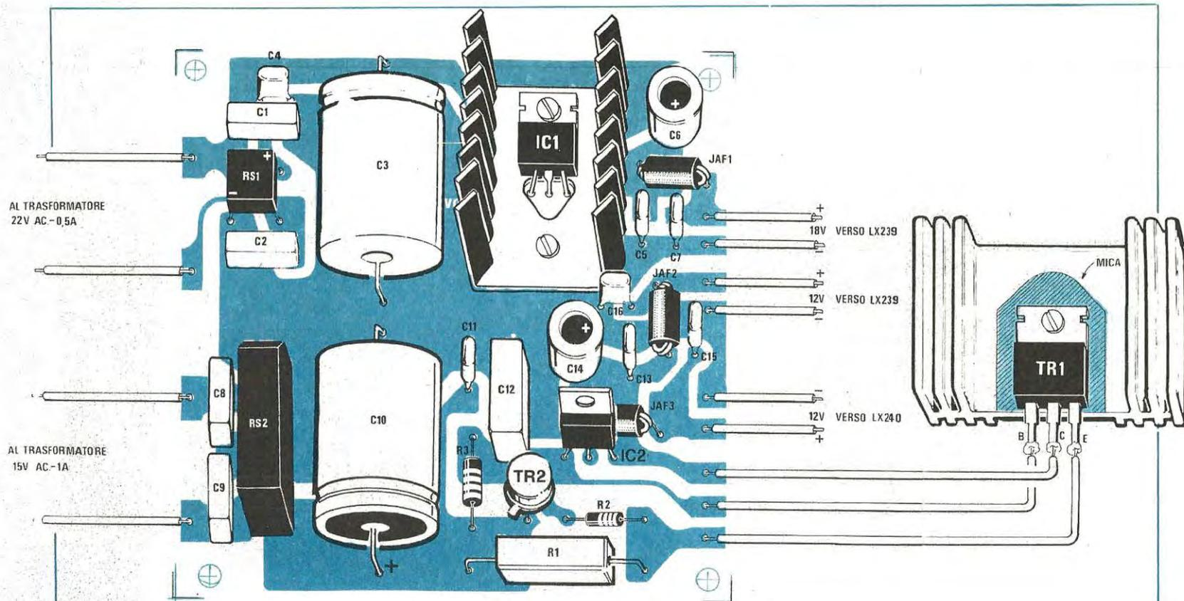
**Fig. 7** Schema pratico di montaggio del doppio alimentatore. Nel collegare i secondari del trasformatore di alimentazione al circuito stampato cercate di non invertirli, cioè applicate il secondario che eroga 22 volt alternati su RS1 e quello che eroga i 15 volt alternati su RS2.
