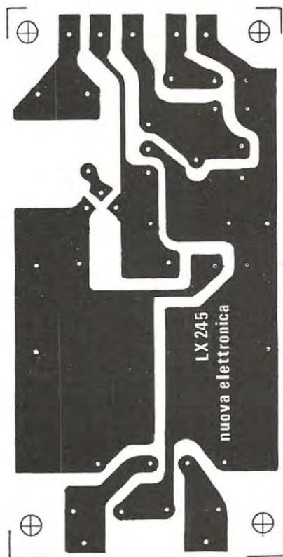
Fig. 5 Disegno a grandezza naturale del circuito stampato necessario per tale realizzazione.
