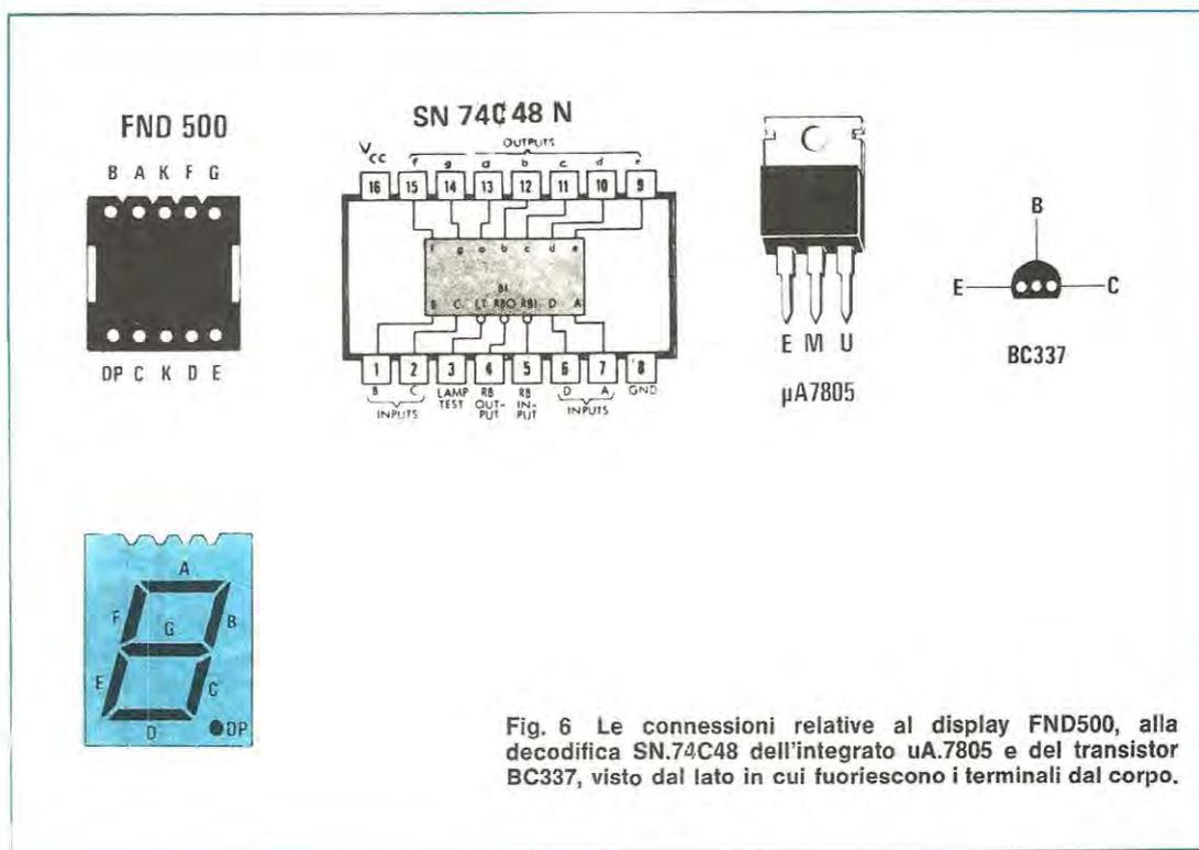
Fig. 6 Le connessioni relative al display FND500, alla decodifica SN.74C48 dell'integrato  $\mu A.7805$  e del transistor BC337, visto dal lato in cui fuoriescono i terminali dal corpo.
