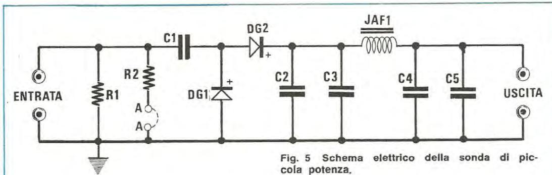
Fig. 5 Schema elettrico della sonda di piccola potenza.
