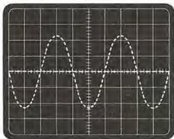
**Fig. 23** Se applichiamo sull'entrata dell'encoder un segnale di BF a 1.000 Hz circa sul punto TP.6 noteremo questa forma di onda, cioè una sinusoida tratteggiata.
