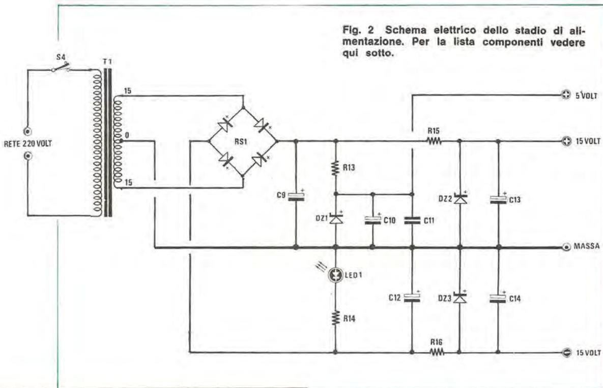
Fig. 2 Schema elettrico dello stadio di alimentazione. Per la lista componenti vedere qui sotto.
