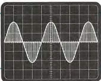
**Fig. 32** Il trimmer R70 lo dovremo ruotare fino ad eliminare l'ondulazione sulla linea centrale visibile in fig. 31. La taratura risulterà perfetta quando riuscirà ad ottenere al centro una linea retta come visibile in questa foto.
