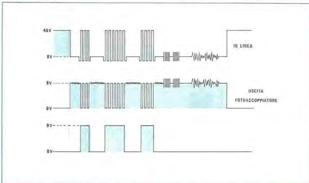
**Fig. 3** Gli impulsi relativi al numero che programmiamo li ritroviamo sul collettore del fototransistor invertiti di polarità e con una ampiezza ridotta a soli 9 volt. Poiché assieme agli impulsi numerici il fotoaccoppiatore rileva anche le frequenze foniche e altre spurie, gli integrati che seguono provvedono ad ottenere un segnale pulito come vedesi in basso.
