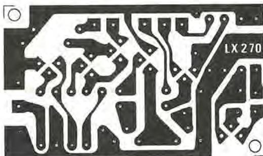
Fig. 2 Disegno a grandezza naturale del circuito stampato e connessioni dei transistor visti da sotto.
