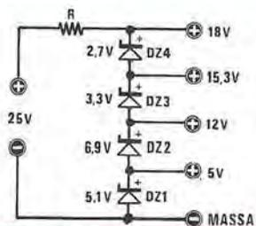
**Fig. 5** Collegando in serie più zener di valore diverso è possibile ricavare, come vedesi in questo schema, una tensione stabilizzata pari alle somme dei diodi impiegati.
