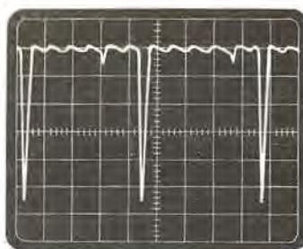
Fig. 15 Forma del segnale a 76 KHz, disponibile sul terminale di controllo TP.2.
