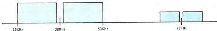
Fig. 4 In molti encoder non è presente un filtro passa-basso a 53-54 KHz ed in questo caso, come vedesi qui sopra, viene irradiata in antenna anche la seconda e la terza armonica dei 38 KHz, cioè i 76 KHz e i 152 KHz, le quali generano fenomeni di intermodulazione. Il filtro passa-basso, come vedesi qui sotto, ci permette di eliminare tutte le armoniche e quindi eliminare sovrarmodulazioni.
