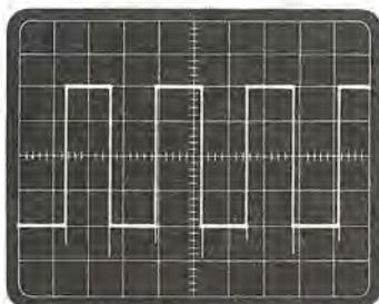
Fig. 20 Sul punto TP.6 ancor prima di regolare il trimmer R27 potremo rilevare ancora un'onda quadra alla frequenza di 38 mila Hz.
