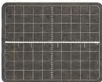
Fig. 21 Il trimmer R27 andrà ruotato fino ad eliminare completamente l'onda quadra, cioè ottenere una linea rettilinea come vedesi nella foto.
