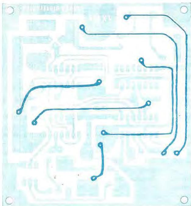
Fig. 6 Di lato il circuito stampato a doppia faccia siglato LX.271 riprodotto a grandezza naturale necessario per la realizzazione di questo progetto.
