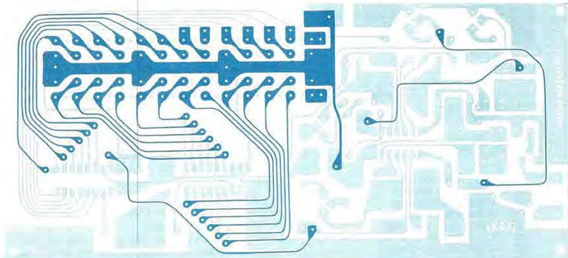
**Fig. 3** Disegno (leggermente ridotto di dimensioni) del circuito stampato a doppia faccia, necessario per la realizzazione di questo indicatore di livello stereo.
