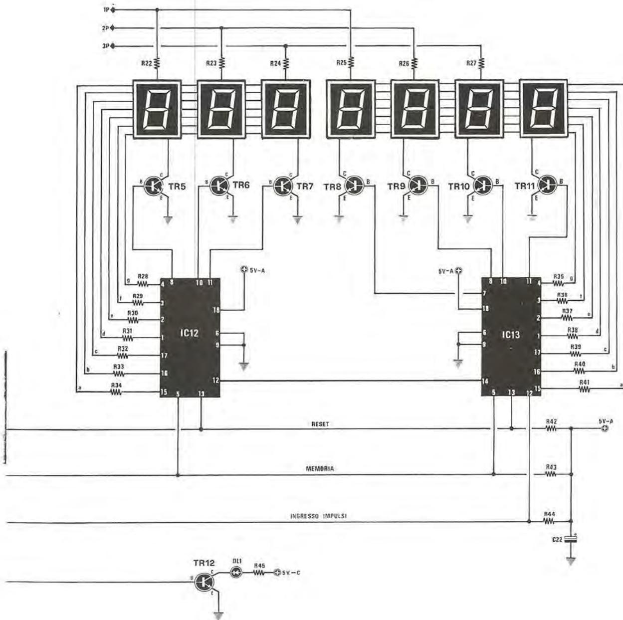
NOTA - Se sulla portata BF i display visualizzano una frequenza di circa 3.000-4.000 Hz anche in assenza di segnale in ingresso, si può ovviare all'inconveniente montando il preamplificatore di BF a parte sul circuito stampato LX303 presentato sulla rivista 60/61.
