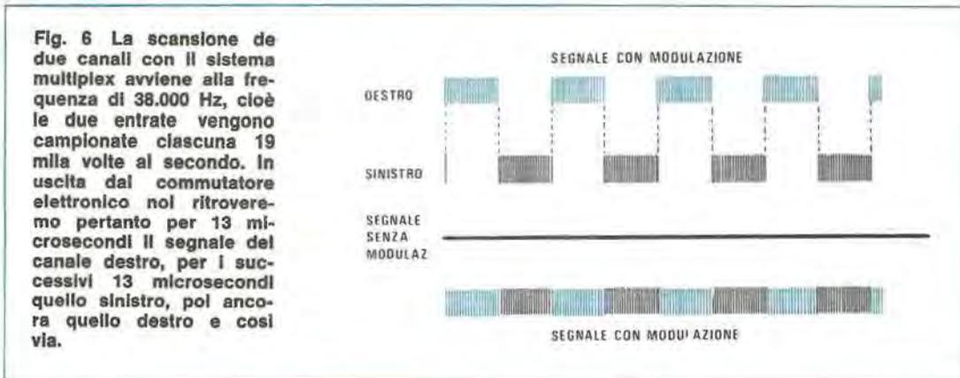
Fig. 6 La scansione dei due canali con il sistema multiplex avviene alla frequenza di 38.000 Hz, cioè le due entrate vengono campionate ciascuna 19 mila volte al secondo. In uscita dal commutatore elettronico noi ritroveremo pertanto per 13 microsecondi il segnale del canale destro, per i successivi 13 microsecondi quello sinistro, poi ancora quello destro e così via.
