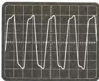
Fig. 14 Forma del segnale a 456 KHz disponibile sul terminale di controllo TP.1
