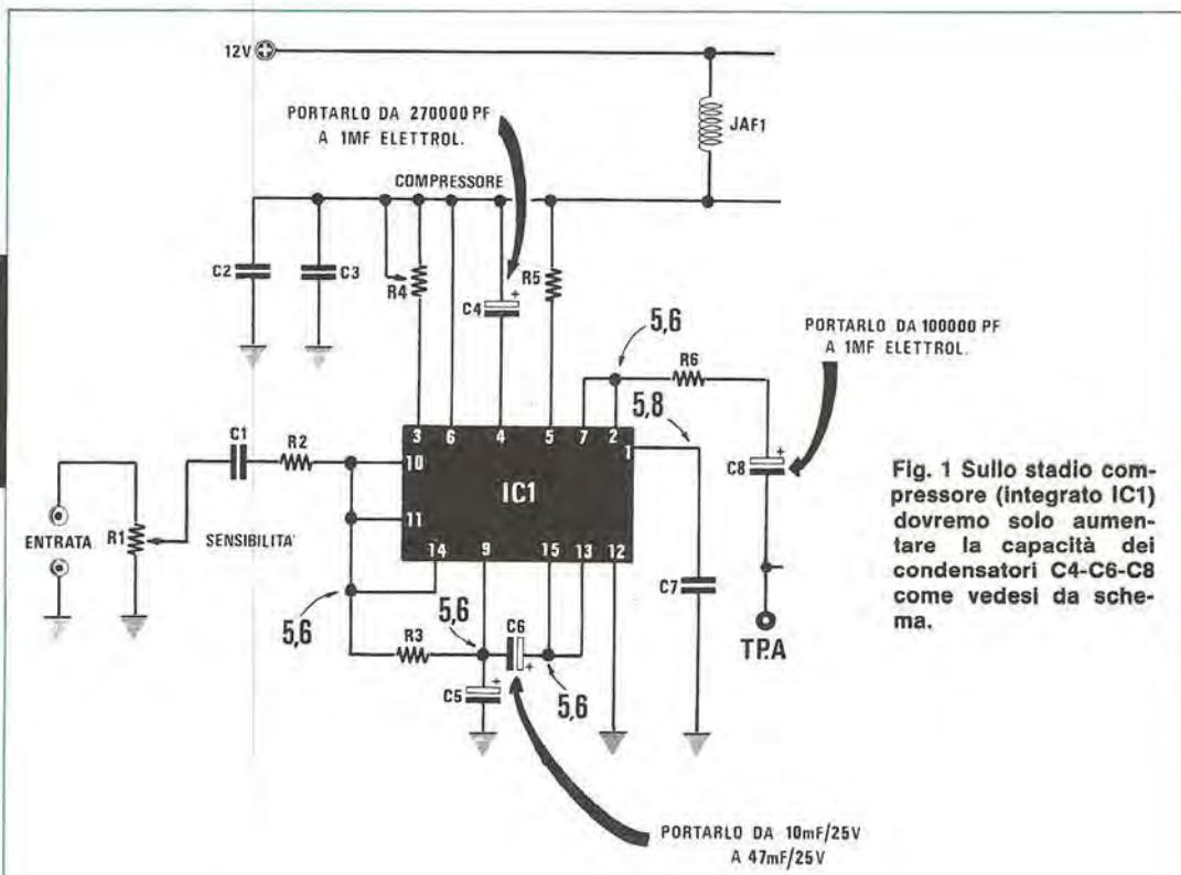
Fig. 1 Sullo stadio compressore (integrato IC1) dovremo solo aumentare la capacità dei condensatori C4-C6-C8 come vedesi da schema.
