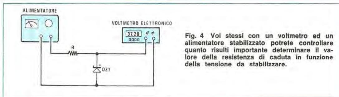
Fig. 4 Voi stessi con un voltmetro ed un alimentatore stabilizzato potrete controllare quanto risulti importante determinare il valore della resistenza di caduta in funzione della tensione da stabilizzare.
