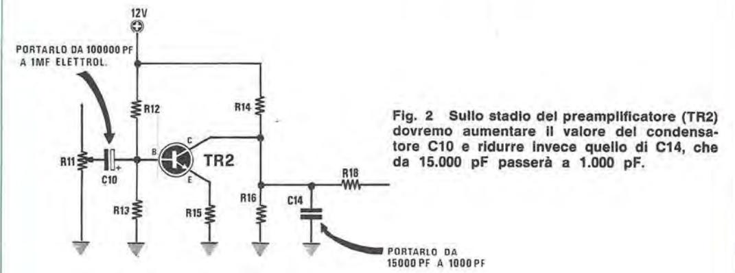
Fig. 2 Sullo stadio del preamplificatore (TR2) dovremo aumentare il valore del condensatore C10 e ridurre invece quello di C14, che da 15.000 pF passerà a 1.000 pF.
