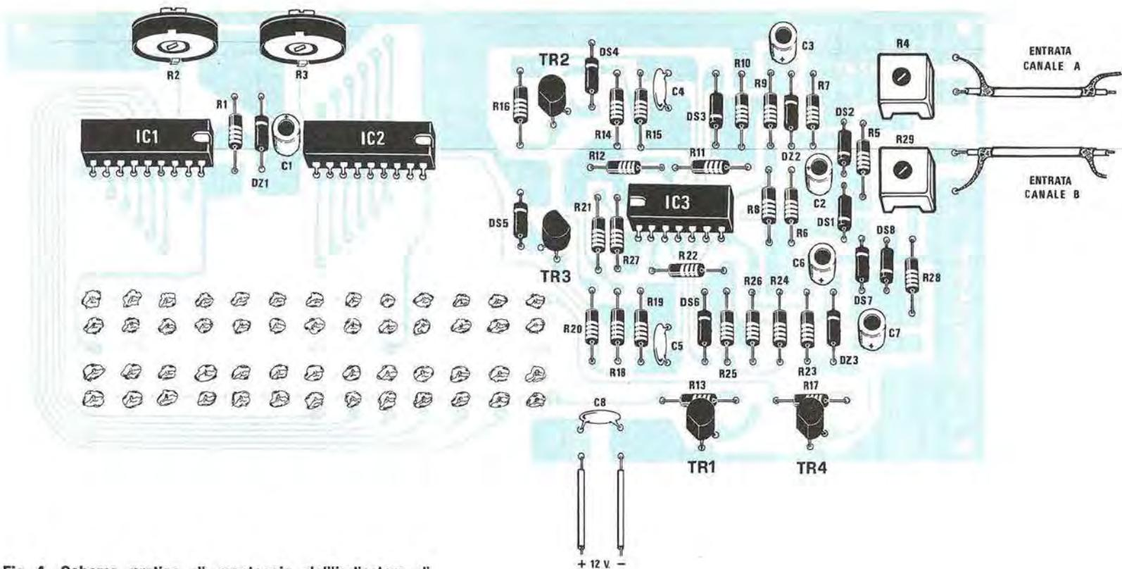
Fig. 4 Schema pratico di montaggio dell'indicatore di livello stereo visto dal lato componenti. Dato l'elevato assorbimento si consiglia di alimentare questo circuito con un qualsiasi alimentatore separato che eroghi 12 volt 100 milliamperè circa.
