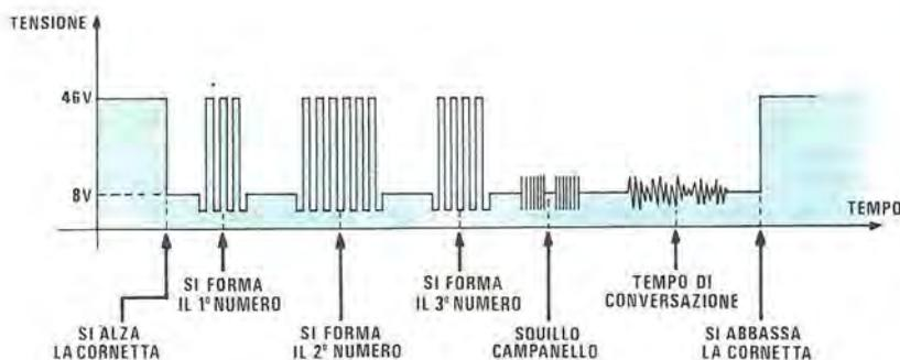
**Fig. 2** Quando alziamo la cornetta nel nostro telefono, la tensione di linea da 46-48 volt circa, scende ad un valore di 8 volt. Ogni numero che formiamo otteniamo degli impulsi con un'ampiezza massima di 46-48 volt come vedesi in disegno. La tensione sfruttata per la conversazione si aggira normalmente sugli 8-15 volt.
