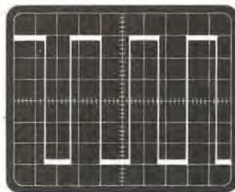
Fig. 16 Sui terminali TP.4 e TP.5 sarà presente quest'onda quadra a 38.000 Hz (38 KHz).
