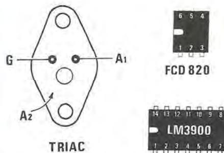
**Fig. 3** Disposizione dei terminali dell'integrato LM.3900 del fotoaccoppiatore e del triac impiegati per questo progetto.
