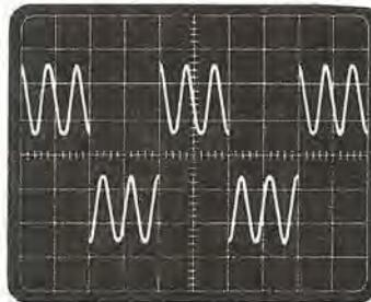
**Fig. 6** La scansione «alternata» è invece idonea per visualizzare frequenze superiori ai 2.000 Hz altrimenti, come vedesi nella foto (abbiamo sempre visualizzate due sole facce) le forme d'onda sullo schermo risulterebbero incomplete.
