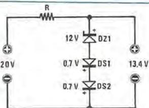
Fig. 3 In serie al diodo zener è possibile collegare anche due o tre diodi al silicio ottenendo per ogni diodo inserito un aumento di 0,7 volt. Due diodi al silicio in serie ad uno zener da 12 volt ci darà una tensione di 13,4 volt.
