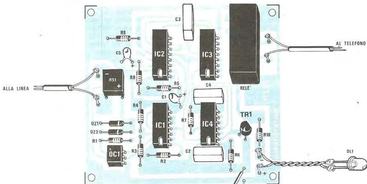
Fig. 7 Schema pratico di montaggio. Controllare prima di inserirli la polarità dei condensatori al tantalio C1-C5 e la tacca di riferimento per gli integrati. Il fotocaccoppiatore OC1 anziché disporre di una tacca di riferimento, presenta un piccolo punto in corrispondenza del terminale 1°.
