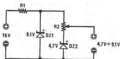
**Fig. 6** Se ci necessita una tensione variabile compresa tra un valore minimo e massimo ben definiti, si può sfruttare lo schema qui visibile.
