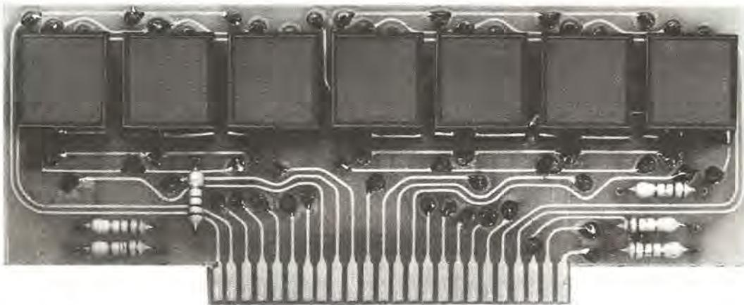
Come si presenta a realizzazione ultimata la basetta portadisplay. Si notino tutte le saldature necessarie per poter collegare in questo circuito le piste inferiori con quelle superiori. Si raccomanda nelle stagnature di non usare pasta salda onde evitare che questa provochi involontariamente dei contatti elettrici tra piste adiacenti.
