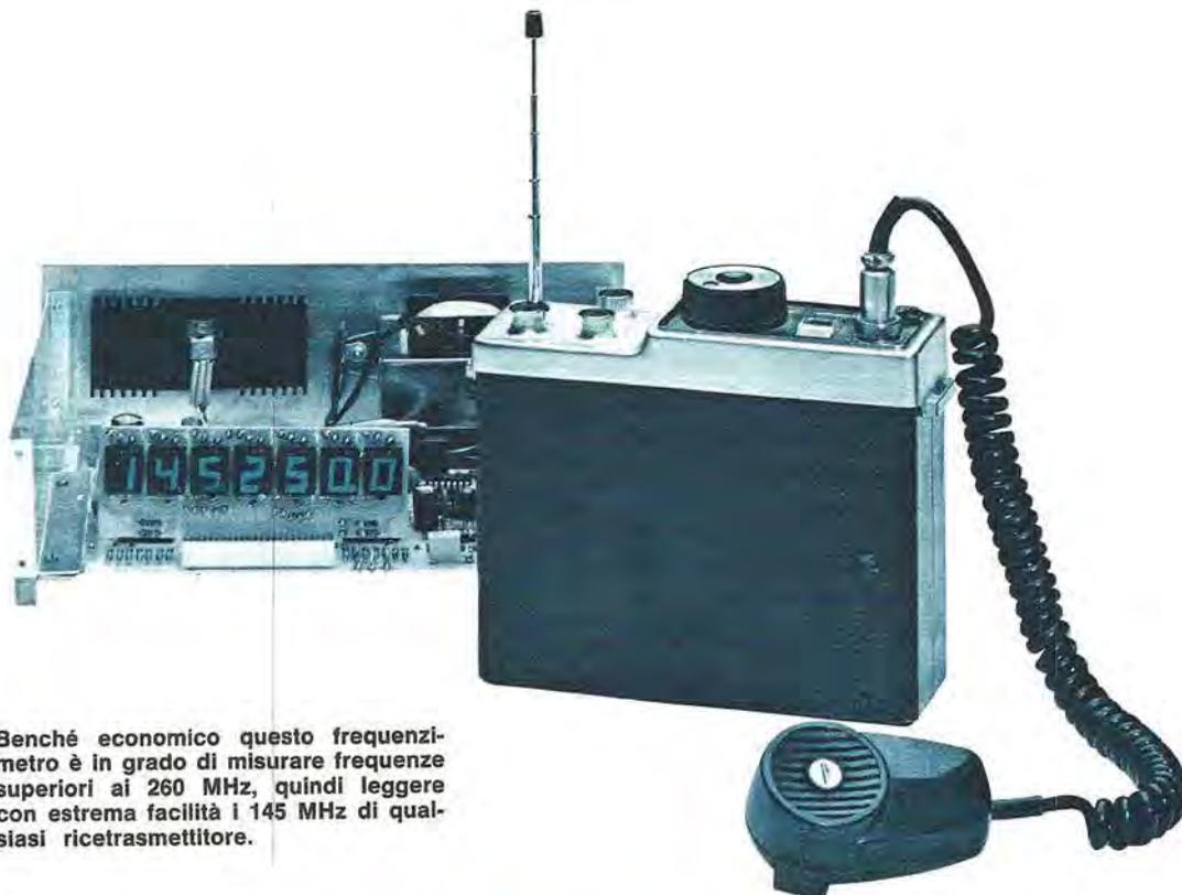
Benché economico questo frequenzimetro è in grado di misurare frequenze superiori ai 260 MHz, quindi leggere con estrema facilità i 145 MHz di qualsiasi ricetrasmittitore.
