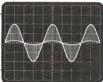
**Fig. 31** Applicando ad uno solo degli ingressi dell'encoder un segnale di BF su TP.9 non avendo ancora tarato il trimmer R70, noteremo che la linea centrale risulta leggermente ondulata come vedesi in questa foto.
