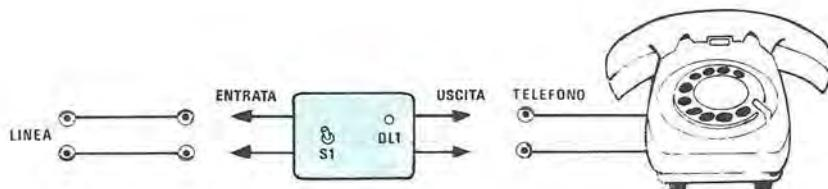
**Fig. 1** Per dotare il vostro telefono dell'antiselezione, sarà sufficiente collegare i due fili della linea sui terminali «entrata» del nostro circuito e collegare quelli che provengono dall'apparecchio telefonico sui terminali «uscita». Non è necessario rispettare la polarità dei due fili.
