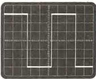
Fig. 18 Sul terminale di controllo TP.3 potremo invece visualizzare la frequenza della portante che come sappiamo è di 19.000 Hz.
