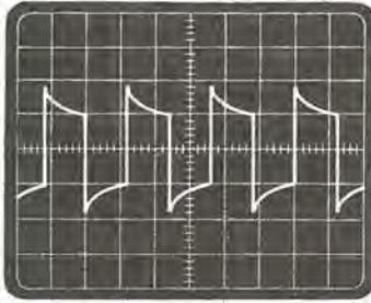
**Fig. 9** Applicando sugli ingressi del quadruplicatore di tracce un'onda quadra alla frequenza di 1.000-2.000 Hz ed inserendo quindi l'attenuatore, sullo schermo potrà apparirvi una forma d'onda simile a quella di sinistra: in tal caso, ruotando i compensatori presenti sul circuito, dovrete cercare di ottenere un'onda quadra perfetta, come vedesi nella foto di destra.
