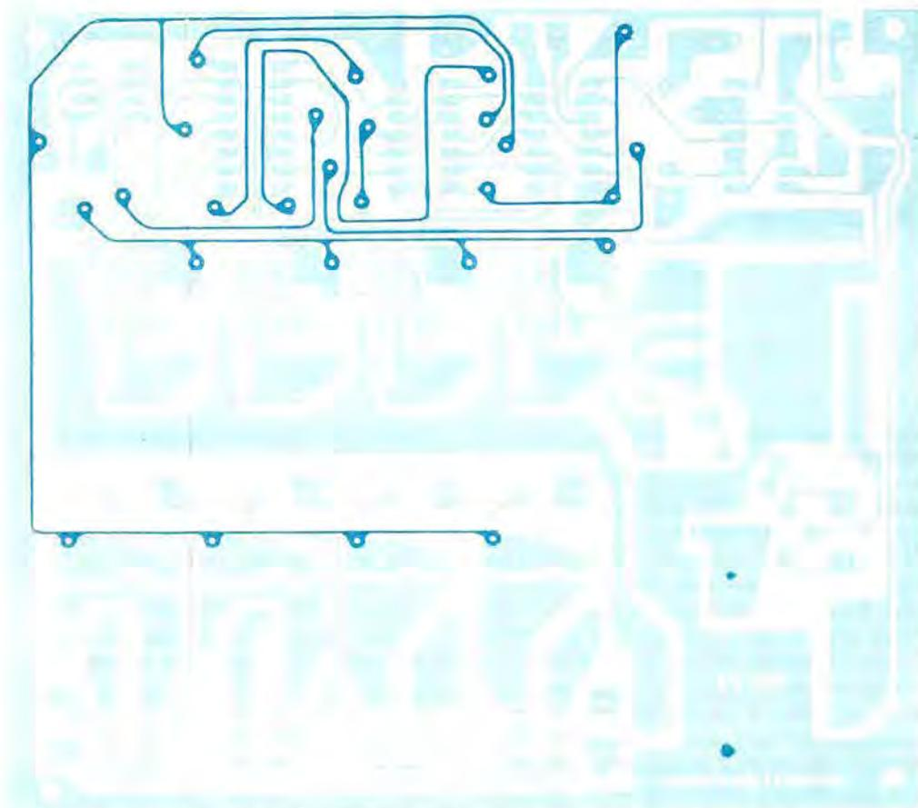
**Fig. 7** Disegno a grandezza naturale del circuito stampato LX266. Tale circuito, in fibra di vetro, è a doppia faccia; quindi occorre collegare, come spiegato nell'articolo, le piste inferiori con quelle superiori sfruttando gli appositi fori di passaggio.
