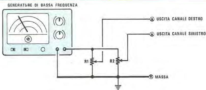
**Fig. 25** Se vogliamo applicare agli ingressi dell'encoder due segnali in fase e dosabili in ampiezza potremo sfruttare lo schema visibile in figura. I valori dei due potenziometri (R1-R2) risultano entrambi da 10.000 ohm lineari.
