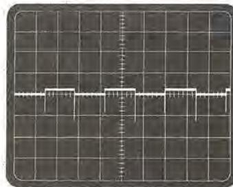
Fig. 22 Se il trimmer R27 non è tarato in modo perfetto si potrà intravedere anziché una linea rettilinea un'onda quadra leggermente pronunciata.
