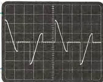
**Fig. 34** Per una perfetta messa a punto della fase, dovremo ora ruotare il trimmer R.58 fino a trasformare la forma d'onda visibile in fig. 33 in una identica alla foto qui riportata.
