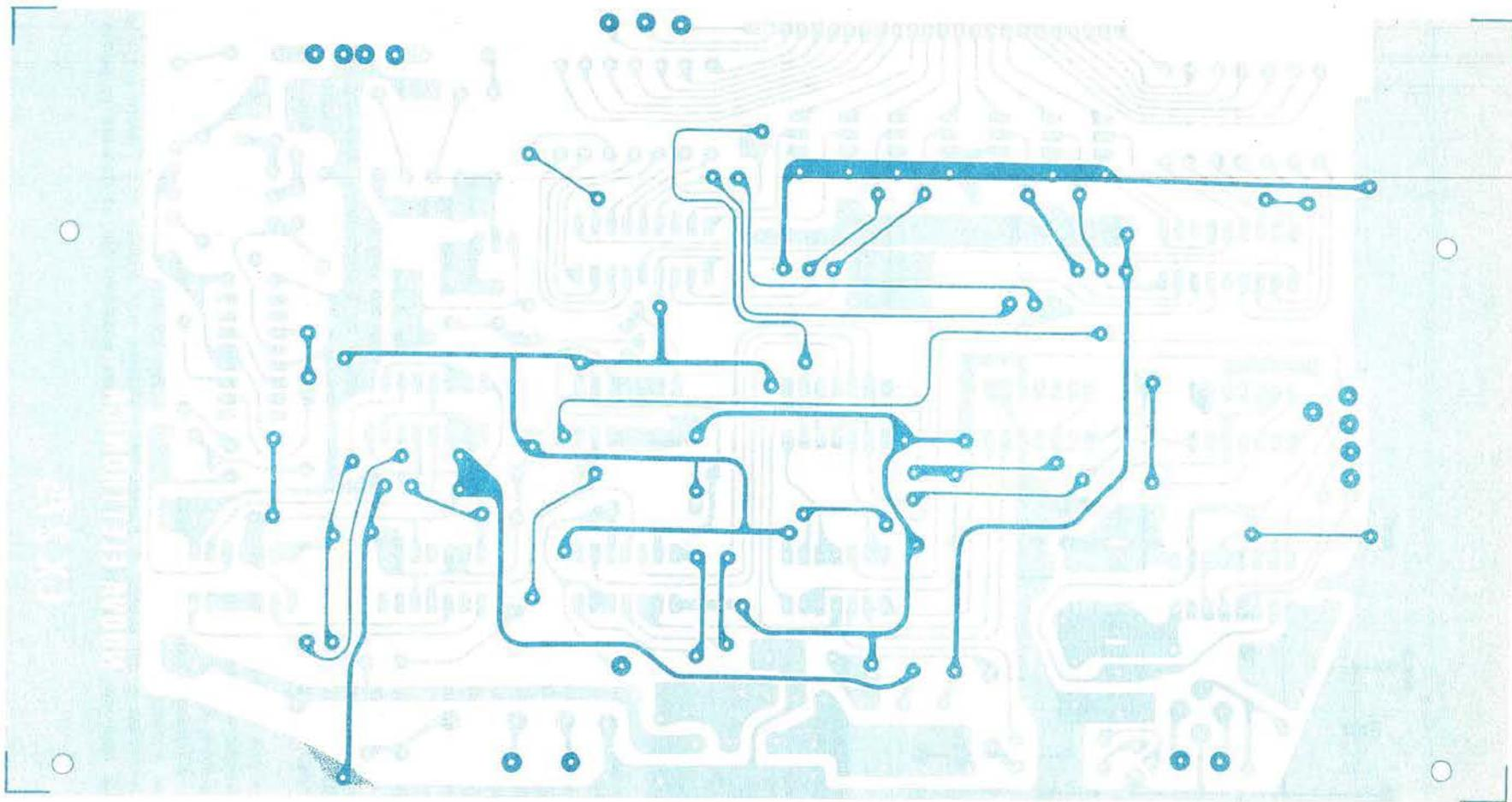
Fig. 4 Il circuito stampato principale di questo frequenzimetro, a doppia faccia, è visibile in questo disegno leggermente ridotto per poterlo includere nel formato della pagina della rivista. Tale circuito è completo sul lato opposto del disegno serigrafico di tutti i componenti.
