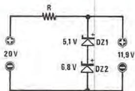
Fig. 1 Collegando in serie due diodi zener, anche di tensioni diverse, si otterrà come risultato una tensione stabilizzata pari alla somma dei valori degli zener impiegati.
