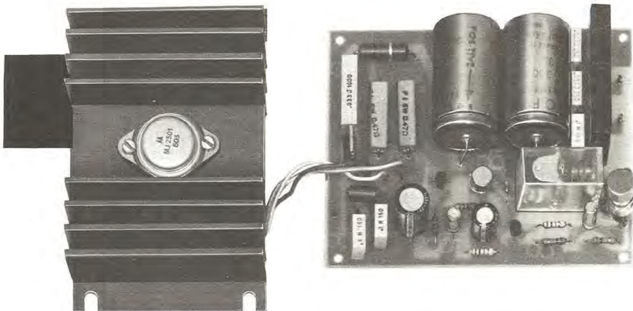
**Foto dell'alimentatore per TTL protetto contro i cortocircuiti e le sovratensioni. Questo alimentatore è in grado di erogare un massimo di oltre 5 amper senza residui di alternata. Si raccomanda nel fissare il darlington MJ.2501 sull'aletta di raffreddamento di isolarlo con le apposite miche e rondelle incluse nel kit.**
