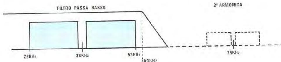
perché un altro 45% viene sfruttato per il segnale stereo e il restante 10% per le portante stereo a 19 KHz. Qualcuno, a questo punto, si chiederà che bisogno c'è di trasmettere il segnale « mono » quando già viene trasmesso quello « stereo ».
