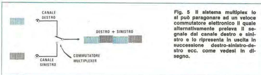
Fig. 5 Il sistema multiplex lo si può paragonare ad un veloce commutatore elettronico il quale alternativamente preleva il segnale dal canale destro e sinistro e lo ripresenta in uscita in successione destro-sinistro-destro ecc. come vedesi in disegno.
