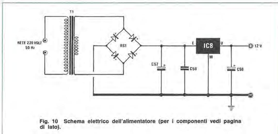
Fig. 10 Schema elettrico dell'alimentatore (per i componenti vedi pagina di lato).
