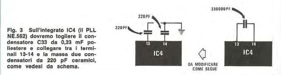
Fig. 3 Sull'integrato IC4 (il PLL NE.562) dovremo togliere il condensatore C33 da 0,33 mF poliestere e collegare tra i terminali 13-14 e la massa due condensatori da 220 pF ceramici, come vedesi da schema.
