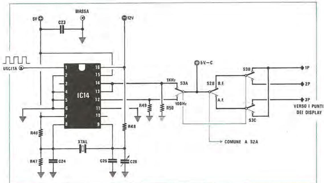
Fig. 3 Schema elettrico dell'oscillatore a quarzo e collegamenti dei due deviatori S2-S3 relativi il primo al passaggio dalla BF alla AF-VHF ed il secondo al cambio della frequenza base da 100 Hz a 1000 Hz.
