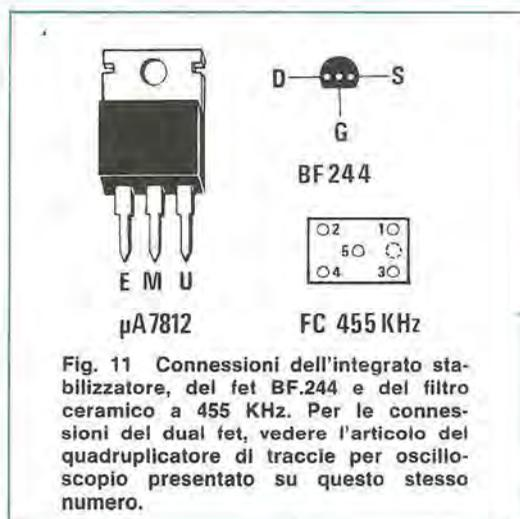
Fig. 11 Connessioni dell'integrato stabilizzatore, del fet BF.244 e del filtro ceramico a 455 KHz. Per le connessioni del dual fet, vedere l'articolo del quadruplicatore di tracce per oscilloscopio presentato su questo stesso numero.
