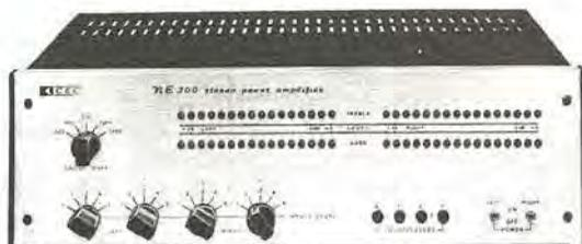
Mobiletto per quattro amplificatori da 60 watt, cross-over elettronico, quattro indicatori di livello a led e due alimentatori per detti.
