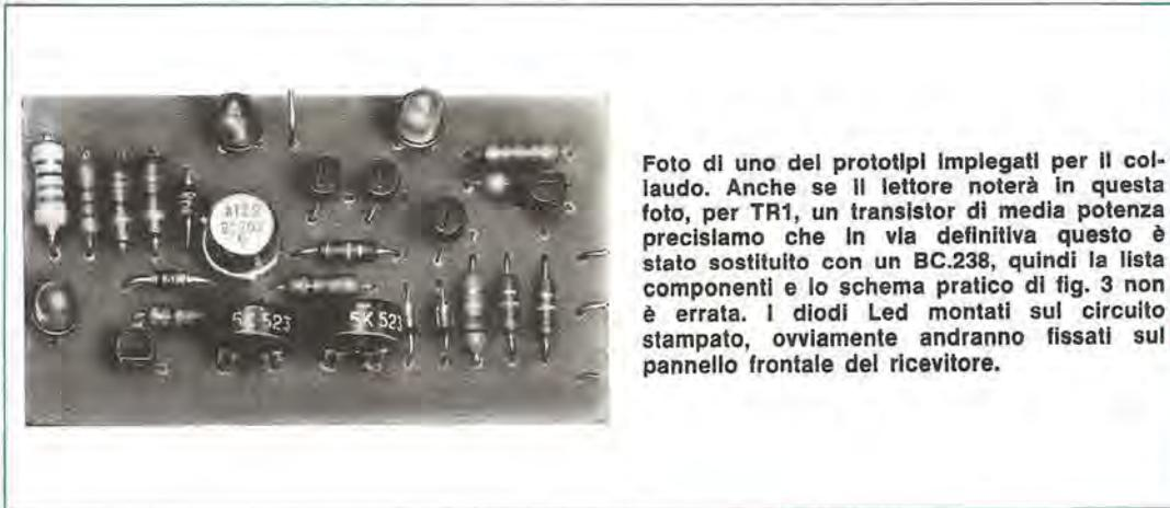
Foto di uno dei prototipi impiegati per il collaudo. Anche se il lettore noterà in questa foto, per TR1, un transistor di media potenza precisiamo che in via definitiva questo è stato sostituito con un BC.238, quindi la lista componenti e lo schema pratico di fig. 3 non è errata. I diodi Led montati sul circuito stampato, ovviamente andranno fissati sul pannello frontale del ricevitore.
