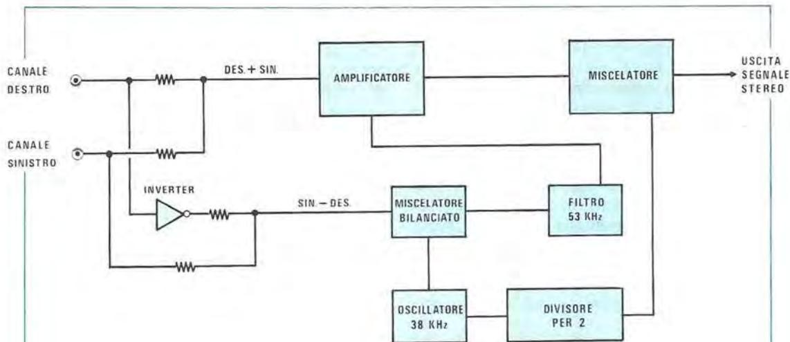
Fig. 3 Un encoder classico sfrutta per trasmettere in stereo un principio di codificazione ormai sorpassato; nel nostro encoder lo spettro di modulazione visibile in fig. 2 lo si ottiene automaticamente con un solo commutatore elettronico, mentre nel classico sono necessari complessi passaggi e miscelezioni con tutti gli inconvenienti derivanti.
