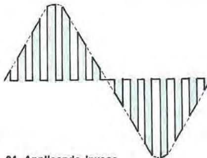
**Fig. 24** Applicando invece una frequenza di circa 5-6.000 Hz potremo maggiormente evidenziare l'effetto della commutazione elettronica a 38.000 Hz, come vedesi in disegno.
