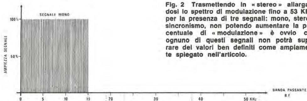
**Fig. 2** Trasmettendo in « stereo » allargandosi lo spettro di modulazione fino a 53 KHz. per la presenza di tre segnali: mono, stereo, sincronismo, non potendo aumentare la percentuale di « modulazione » è ovvio che ognuno di questi segnali non potrà superare dei valori ben definiti come ampiamente spiegato nell'articolo.
