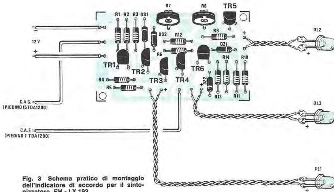
Fig. 3 Schema pratico di montaggio dell'indicatore di accordo per il sintonizzatore FM - LX.193.
