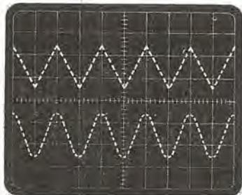
**Fig. 5** Il «chopped» lo si deve utilizzare per la visualizzazione di segnali a frequenza più bassa di 3.000 Hz, diversamente le tracce sullo schermo (ne abbiamo visualizzate solo due per meglio evidenziare questo particolare) potrebbero apparire «tratteggiate».
