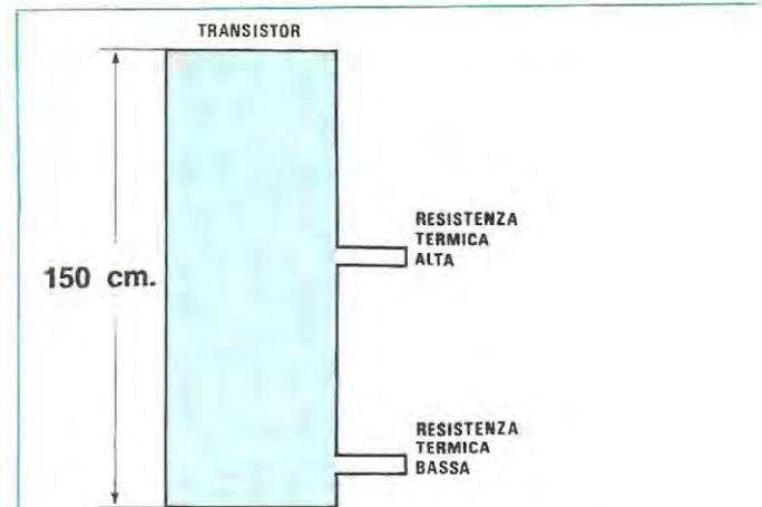
**Fig. 3** Facendo un paragone idraulico, il transistor può essere considerato come un cilindro pieno d'acqua provvisto di uno sfogo laterale e la potenza da dissipare come un cilindro in sughero da infilare entro tale contenitore. Più potenza vogliamo far dissipare al transistor, più acqua dobbiamo togliere dal cilindro e per ottenere questo è necessario applicare il tubo di scarico il più basso possibile.
