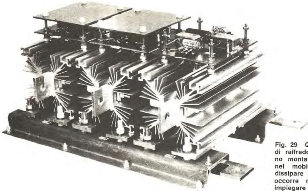
Fig. 29 Quando le alette di raffreddamento vengono montate internamente nel mobile e debbono dissipare molto calore, occorre necessariamente impiegare dei ventilatori per far circolare forzatamente l'aria abbassando così la loro resistenza termica.
