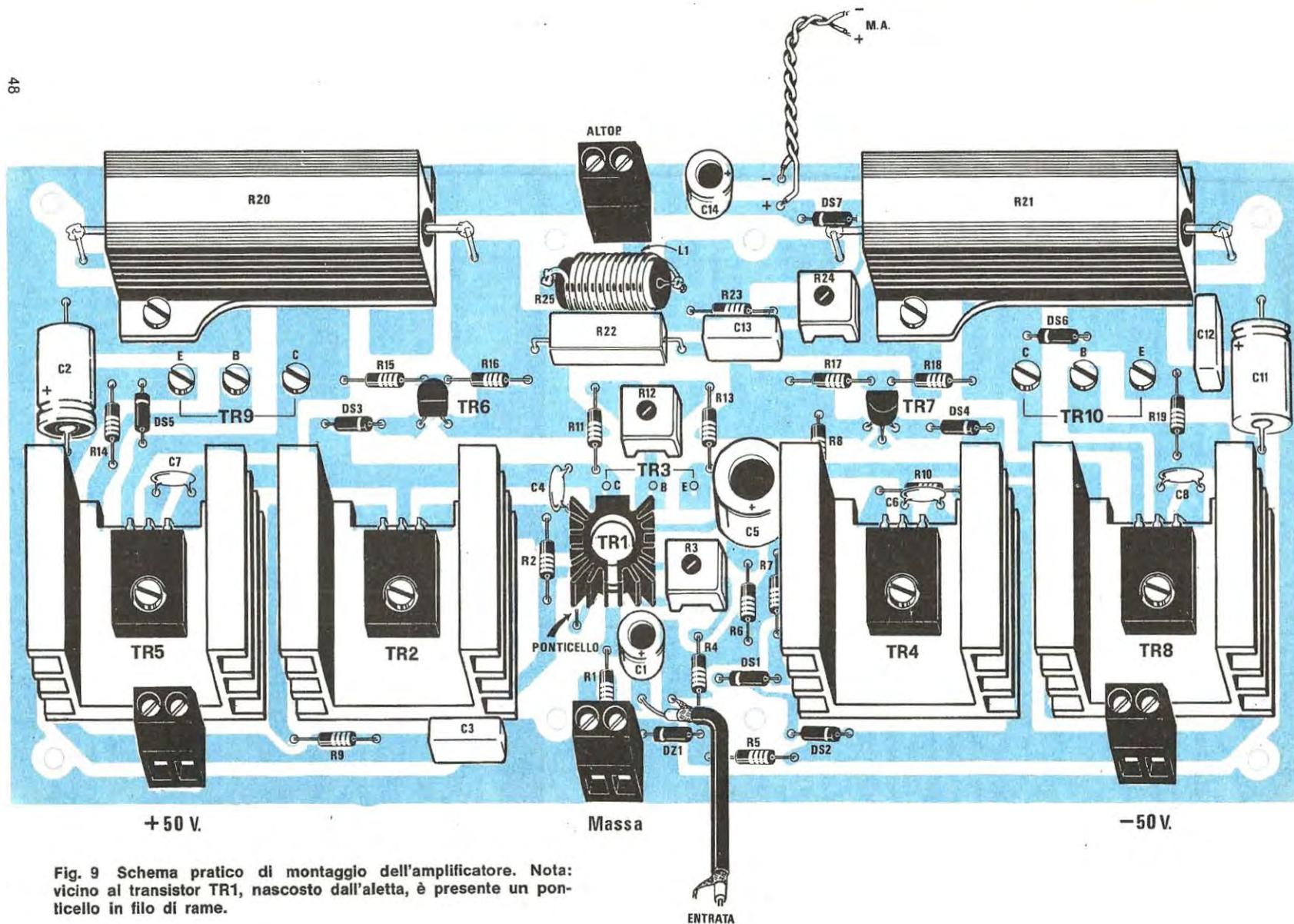
Fig. 9 Schema pratico di montaggio dell'amplificatore. Nota: vicino al transistor TR1, nascosto dall'aletta, è presente un ponticello in filo di rame.
