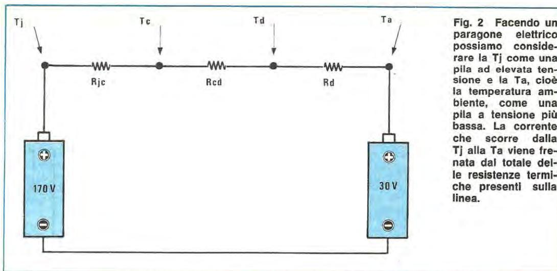
Fig. 2 Facendo un paragone elettrico possiamo considerare la T<sub>j</sub> come una pila ad elevata tensione e la T<sub>a</sub>, cioè la temperatura ambiente, come una pila a tensione più bassa. La corrente che scorre dalla T<sub>j</sub> alla T<sub>a</sub> viene frenata dal totale delle resistenze termiche presenti sulla linea.
