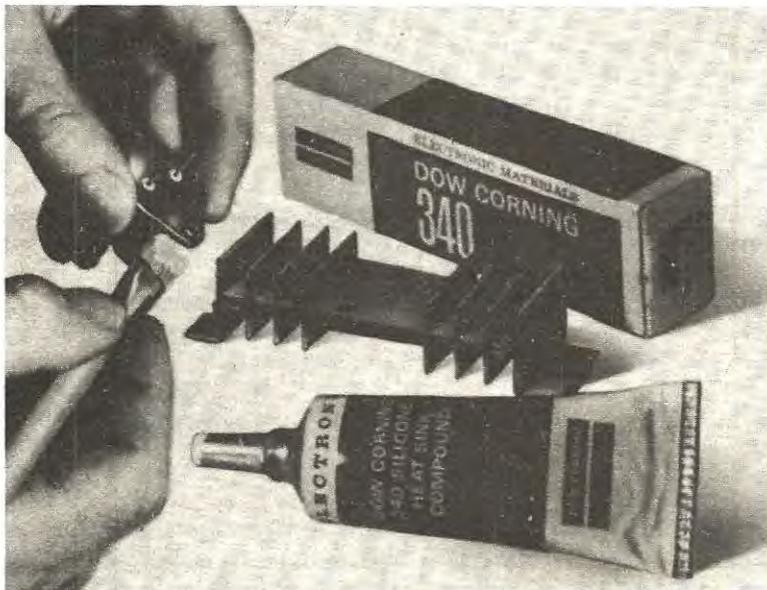
**Fig. 19** Per far dissipare al transistor maggior potenza è più consigliabile fissare direttamente il transistor all'aletta riducendo così la resistenza termica  $R_{cd}$ , poi isolare l'aletta dal metallo del mobile tramite degli appositi distanziatori o con comuni rondelle in plastica. Eliminando la mica, il calore dal corpo del transistor si trasferirà con minor resistenza alla superficie dell'aletta.
