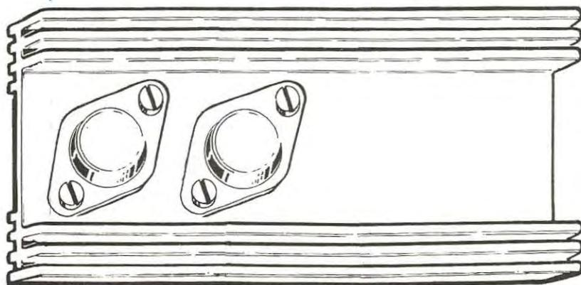
**Fig. 27** Se volete far bruciare i vostri transistor, applicateli tutti su un lato dell'aletta come qui indichiamo. Con un tale montaggio la superficie efficace dell'aletta si riduce in pratica a metà, quindi la resistenza termica aumenta considerevolmente come possiamo vedere dalle tavole a fine articolo.
