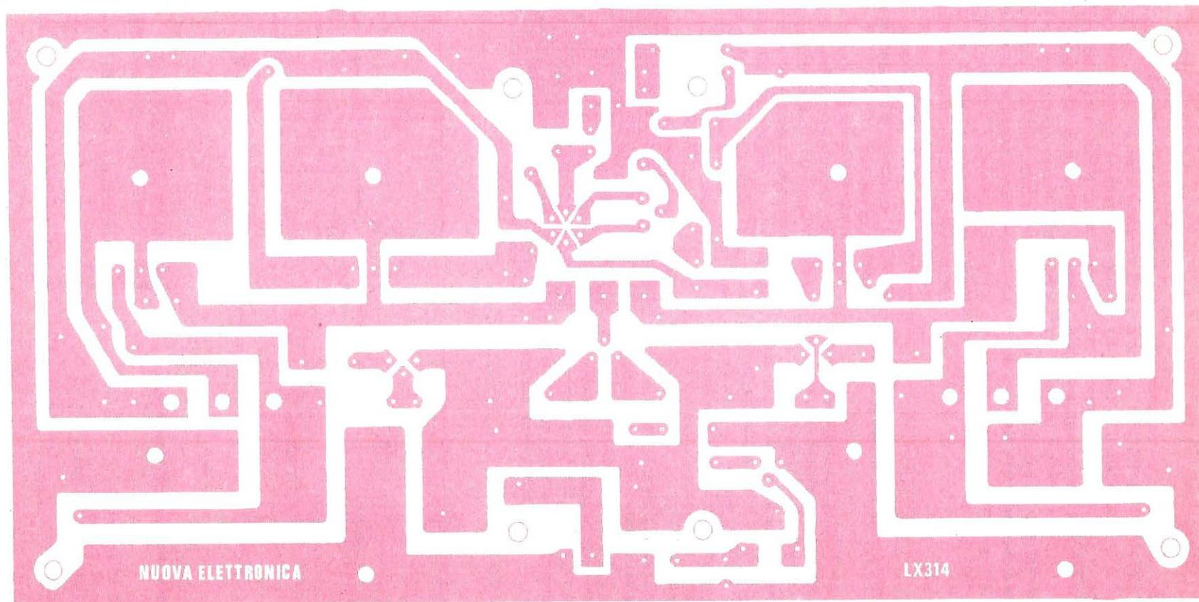
**Fig. 8** Circuito stampato a grandezza naturale necessario per la realizzazione dell'amplificatore da 200 watt. Questo circuito in fibra di vetro viene fornito già forato e completo di disegno serigrafico.
