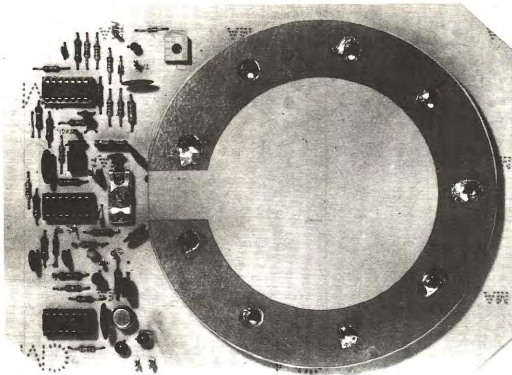
La bobina esploratrice va avvolta, come spieghiamo nell'articolo, entro il rocchetto che si ottiene sovrapponendo al circuito stampato base (quello sul quale sono applicati tutti i componenti) un secondo circuito stampato circolare provvisto nella parte superiore di una fascia di rame che funge da schermo per la bobina.
