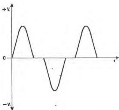
**Fig. 2** Poiché in un classe B i transistor iniziano a condurre solo quando l'ampiezza del segnale applicato sulla base supera il valore minimo di  $V_{BE}$ , cioè all'incirca quando si superano gli 0,6 volt, al passaggio per lo 0 si manifesta sempre un minimo di distorsione d'incrocio.
