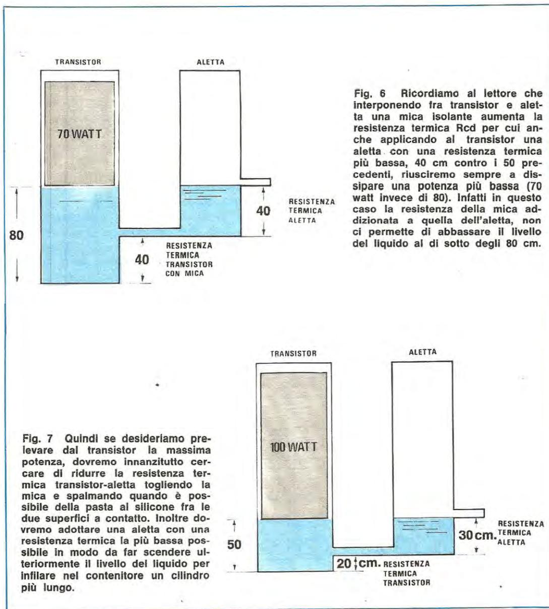
Fig. 6 Ricordiamo al lettore che interponendo fra transistor e aletta una mica isolante aumenta la resistenza termica Rcd per cui anche applicando al transistor una aletta con una resistenza termica più bassa, 40 cm contro i 50 precedenti, riusciremo sempre a dissipare una potenza più bassa (70 watt invece di 80). Infatti in questo caso la resistenza della mica addizionata a quella dell'aletta, non ci permette di abbassare il livello del liquido al di sotto degli 80 cm.
