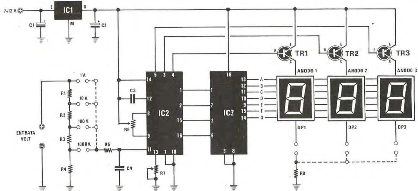
Fig. 3 Schema elettrico completo del voltmetro.
