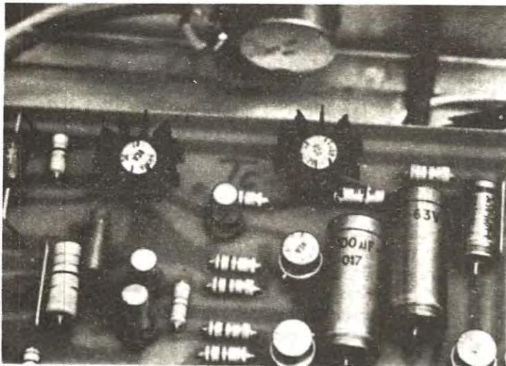
**Fig. 16** Applicando le normali alette a raggiera sui transistor con involucro in TO.5 dovremo cercare di non allargare troppo l'aletta perché se questa non è ben aderente al corpo del transistor, non sarà in grado di prelevare il calore generato ed il transistor se ne andrà in fumo.
