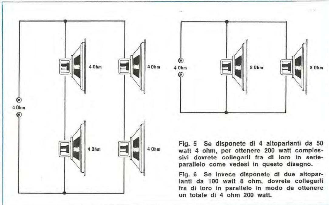
**Fig. 5** Se disponete di 4 altoparlanti da 50 watt 4 ohm, per ottenere 200 watt complessivi dovrete collegarli fra di loro in serie-parallelo come vedesi in questo disegno.
