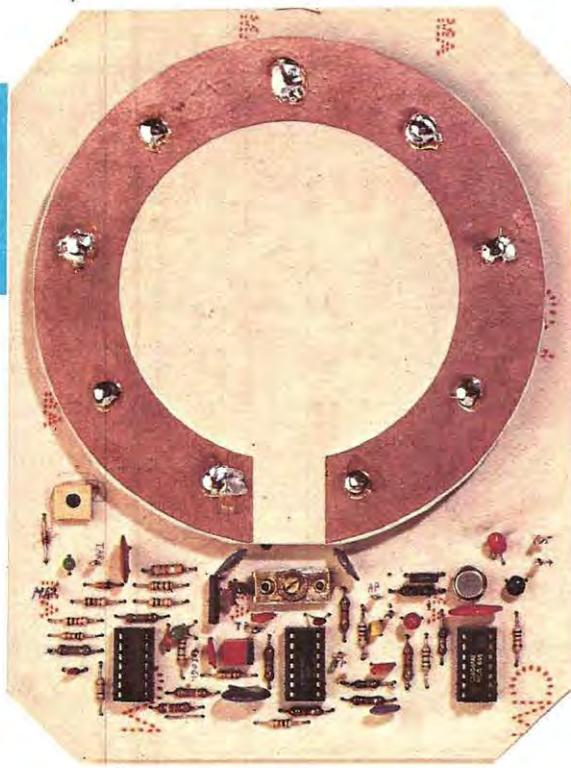
Ecco come si presenta, a realizzazione ultimata, il circuito stampato che raccoglie, assieme ai componenti elettronici, anche la bobina esploratrice completa di schermo elettrostatico per renderla insensibile agli effetti capacitivi.
