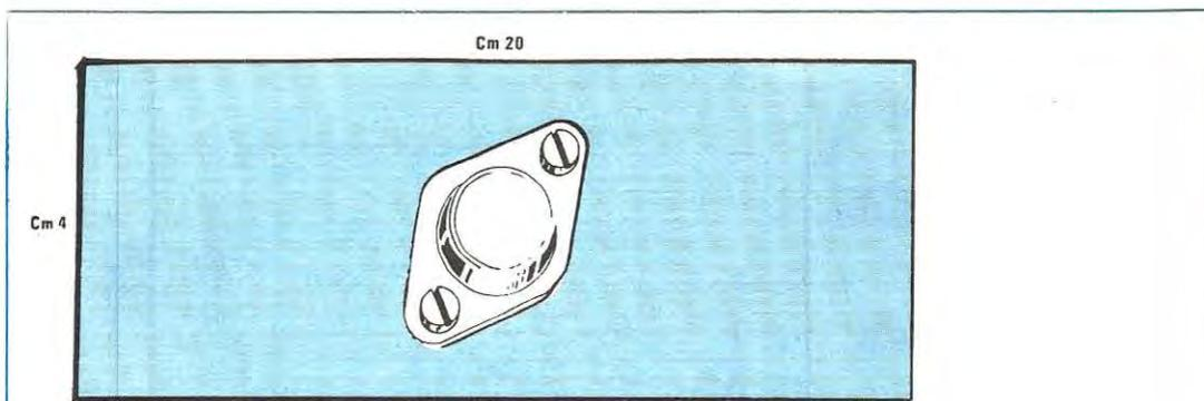
**Fig. 8** È errato calcolarsi la superficie in cmq dell'aletta in quanto la resistenza termica fra l'aletta stessa e l'ambiente esterno varia al variare del profilo, pur essendo identica la superficie complessiva. Per esempio un'aletta di cm 20 x 4, pur avendo all'incirca la stessa superficie di un'aletta di cm 9 x 9, dissipa molto meno calore rispetto a quest'ultima.
