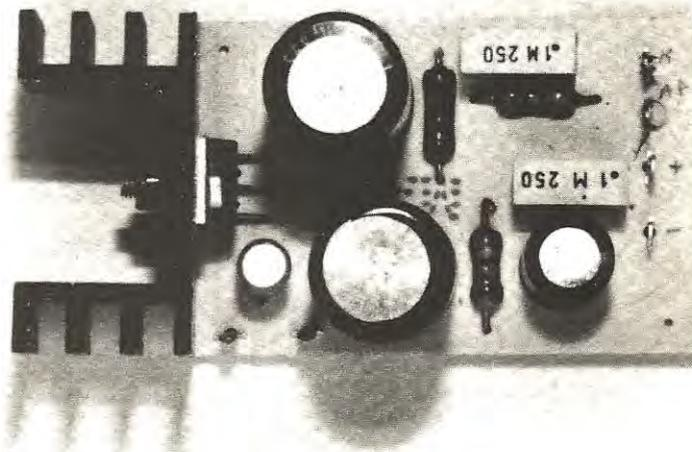
**Un semplice amplificatore di BF in grado di erogare in uscita una potenza variabile da 2 a 8 watt massimi variando solo la tensione di alimentazione e l'impedenza dell'altoparlante.**
