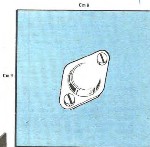
**Fig. 9** Per calcolare esattamente le dimensioni di una aletta occorre conoscere con precisione la resistenza termica richiesta, quindi ricavarla dalle tabelle riportate a fine articolo, la lunghezza idonea per il profilo adottato.
