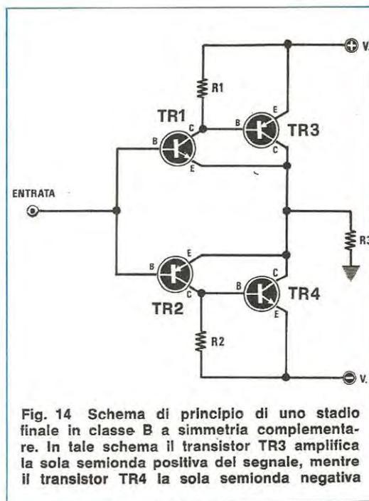
Fig. 14 Schema di principio di uno stadio finale in classe B a simmetria complementare. In tale schema il transistor TR3 amplifica la sola semionda positiva del segnale, mentre il transistor TR4 la sola semionda negativa
