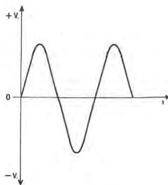
**Fig. 3** Polarizzando leggermente le basi dei transistor in modo che questi conducano anche in assenza di segnale, si elimina questo punto morto e l'onda sinusoidale in uscita non si presenta più spezzata al centro come vedesi in fig. 2, bensì stilisticamente perfetta.
