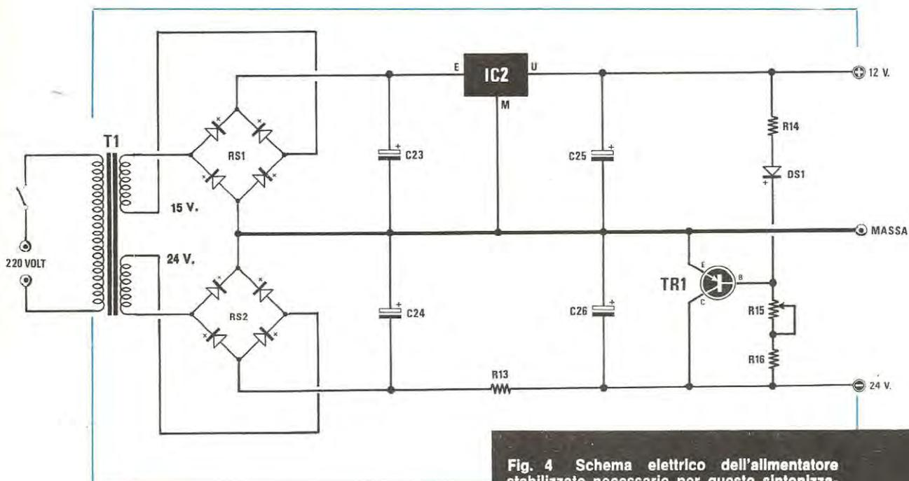
**Fig. 4** Schema elettrico dell'alimentatore stabilizzato necessario per questo sintonizzatore onde medie. Tale alimentatore è parte integrante del circuito, quindi viene direttamente montato, come vedesi in fig. 6, sul circuito stampato LX305. Per i valori dei componenti vedere sotto la fig. 1.
