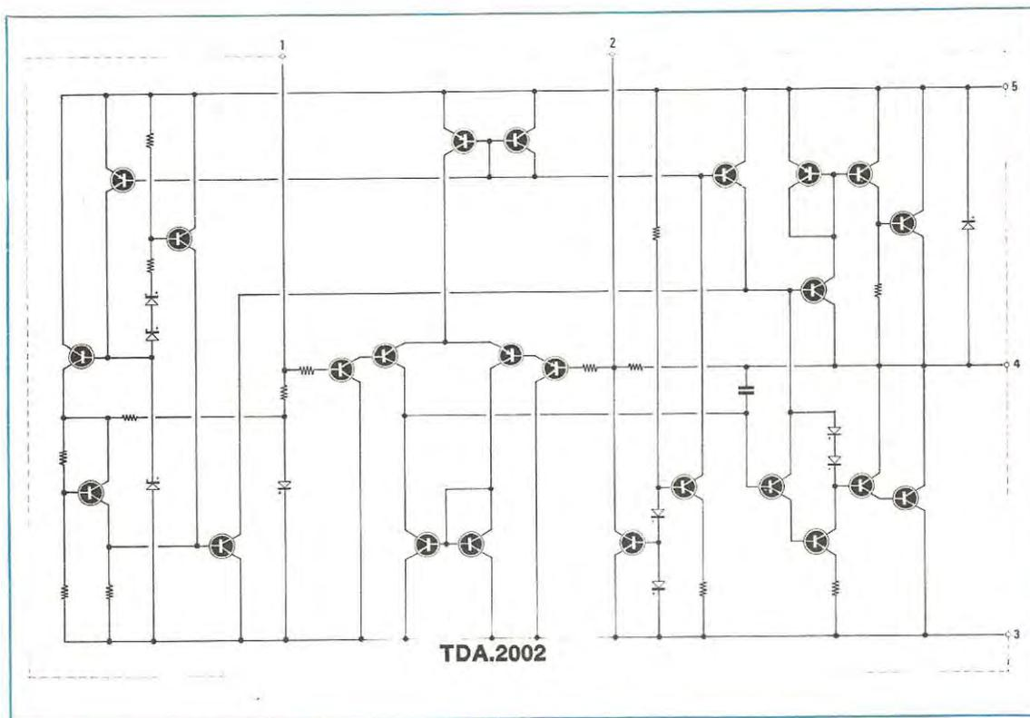
Fig. 2 Schema elettrico interno dell'integrato TDA.2002. Come vedesi in disegno all'interno di questo integrato risultano inclusi ben 24 transistor i quali ci permettono di ottenere un amplificatore che può funzionare indifferentemente con tensioni comprese fra i 12 e i 16 volt, con qualsiasi tipo di altoparlante.
