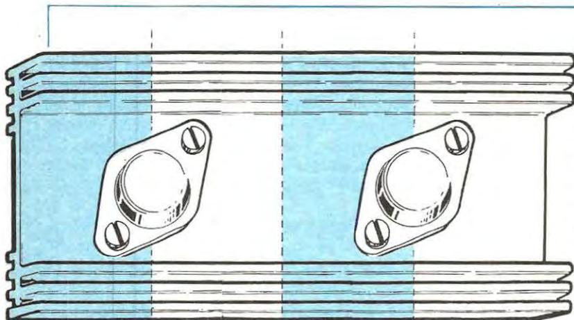
**Fig. 25** Se applicate due transistor su una sola aletta ricordatevi di dividere la lunghezza in quattro parti uguali in modo che ogni transistor disponga su entrambi i lati di una identica superficie come se in pratica affiancassimo due alette separate.
