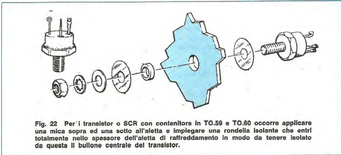
**Fig. 22** Per i transistor o SCR con contenitore in TO.59 e TO.60 occorre applicare una mica sopra ed una sotto all'aletta e impiegare una rondella isolante che entri totalmente nello spessore dell'aletta di raffreddamento in modo da tenere isolato da questa il bullone centrale del transistor.
