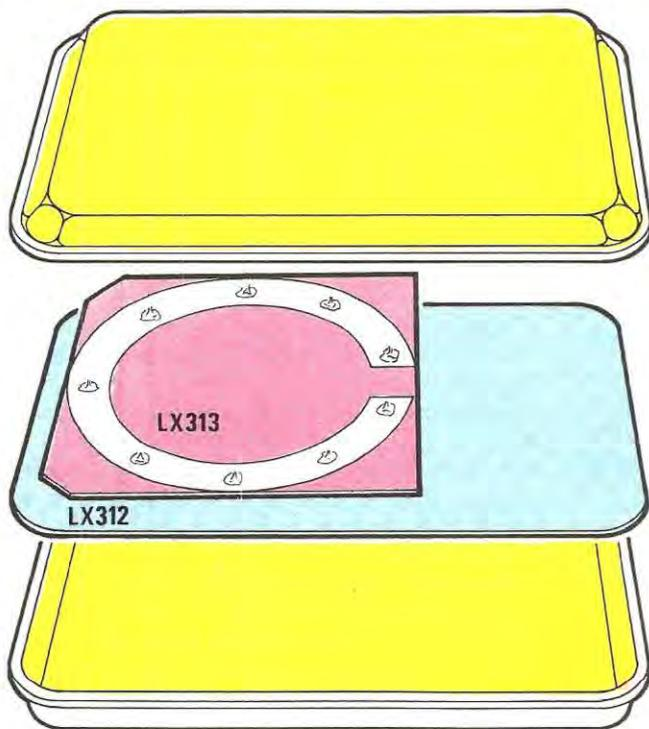
Fig. 6 I due coperchi in plastica appoggiati uno sopra ed uno sotto al circuito stampato LX312 verranno tenuti insieme mediante quattro viti di ottone da 2-3 mm complete di dado che infileremo negli appositi fori praticati in precedenza sui bordi esterni. È pure possibile, anche se meno estetico, fasciare i bordi per tenerli uniti con nastro isolante o cerotto.
