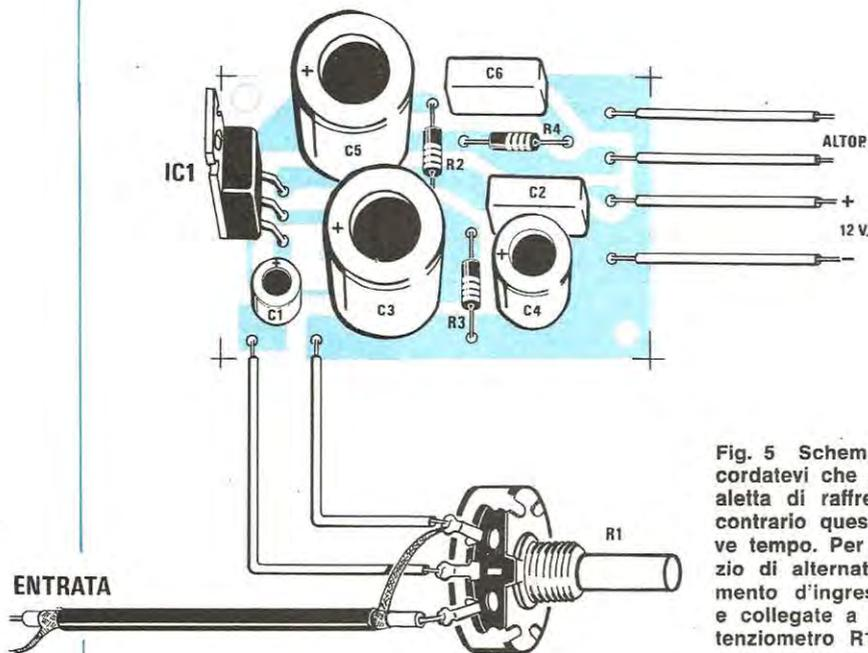
**Fig. 5** Schema pratico di montaggio. Ricordatevi che sull'integrato va fissata una aletta di raffreddamento perché in caso contrario questo può distruggersi in breve tempo. Per evitare di captare del ronzio di alternata, utilizzate per il collegamento d'ingresso del cavetto schermato e collegate a massa la carcassa del potenziometro R1.
