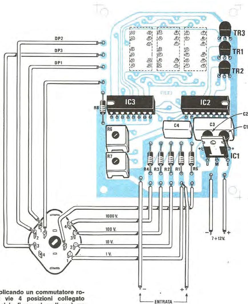
**Fig. 7** Applicando un commutatore rotativo a 2 vie 4 posizioni collegato come vedesi in figura si realizzerà un voltmetro in grado di leggere, in 4 portate, da 1 millivolt a 1.000 volt.
