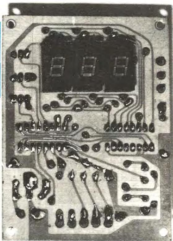
Foto del circuito stampato del voltmetro digitale descritto nell'articolo visto dal lato dei display. Le dimensioni di questo voltmetro sono molto ridotte misurando il circuito stampato cm. 7 x 9.
