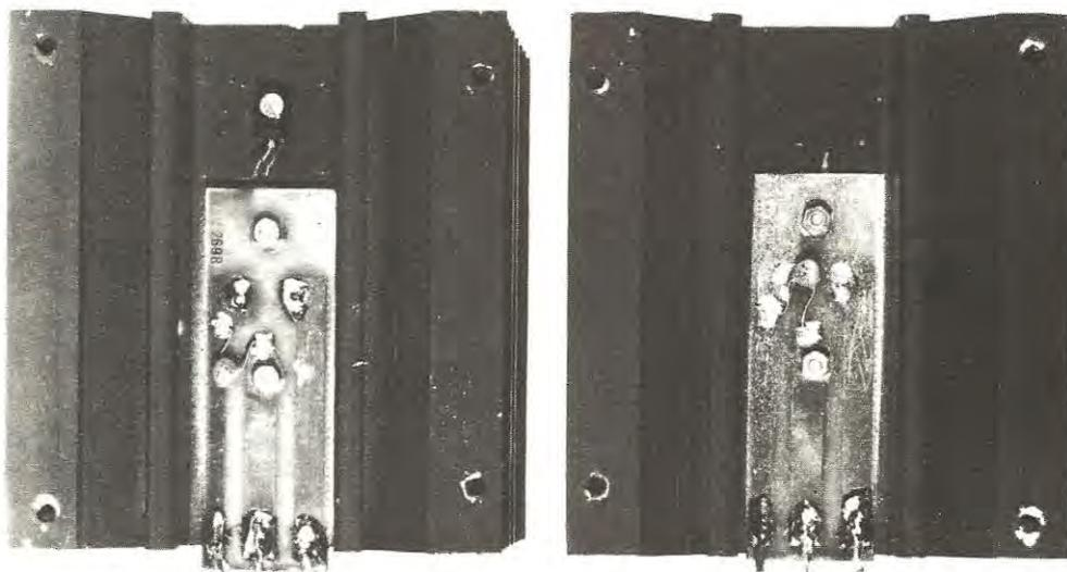
**Fig. 13** Nelle foto le due alette di raffreddamento con sopra montati i transistor finali. Si noti il transistor TR3 fissato su una sola aletta. Ricordiamo al lettore che queste due alette di raffreddamento debbono risultare isolate sia dal circuito stampato LX314, sia dal metallo del mobile, sia fra di loro in quanto una risulta interessata dai 50 volt positivi e l'altra dai 50 volt negativi rispetto alla massa.
