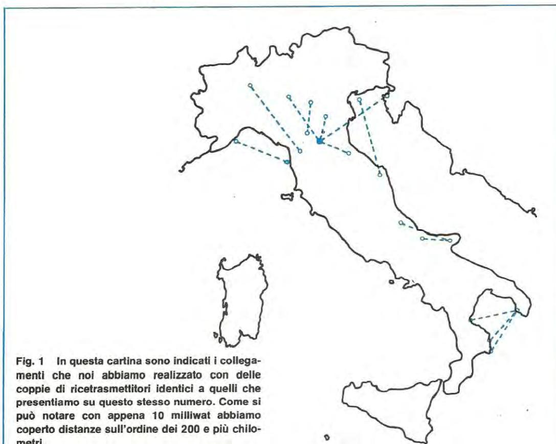
**Fig. 1** In questa cartina sono indicati i collegamenti che noi abbiamo realizzato con delle coppie di ricetrasmittitori identici a quelli che presentiamo su questo stesso numero. Come si può notare con appena 10 milliwat abbiamo coperto distanze sull'ordine dei 200 e più chilometri.
