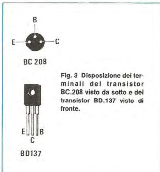
Fig. 3 Disposizione dei terminali del transistor BC.208 visto da sotto e del transistor BD.137 visto di fronte.
