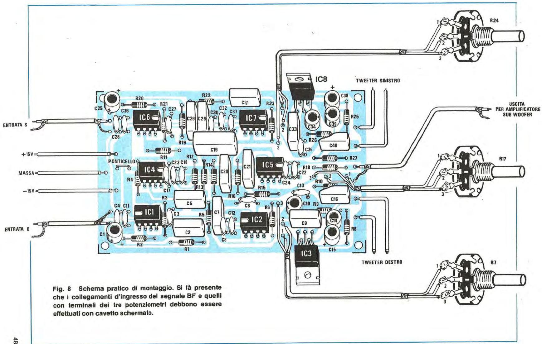
Fig. 8 Schema pratico di montaggio. Si fà presente che i collegamenti d'ingresso del segnale BF e quelli con terminali dei tre potenziometri debbono essere effettuati con cavetto schermato.
