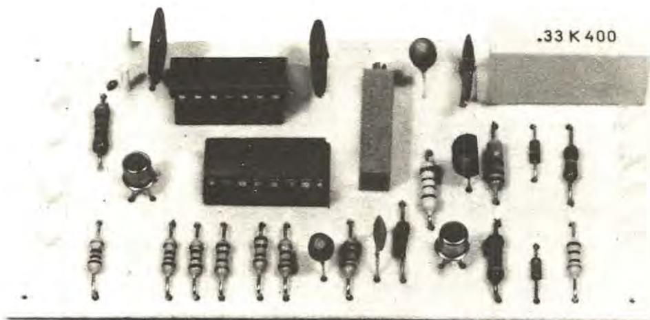
Un semplice e valido preamplificatore, idoneo per frequenzimetri digitali, in grado di accettare in ingresso segnali da un minimo di 15-20 millivolt ad un massimo di 250 volt, con una frequenza massima di lavoro pari a 50-60 MHz, completo pure di divisore X 10.
