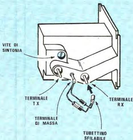
**Fig. 4** Attenzione: sul terminale RX, non dovremo mai stagnare alcun filo. Per effettuare il collegamento fra il circuito stampato e questo terminale dovremo pertanto sfilare il tubicino su di esso applicato, stagnare su questo il filo quindi reinserirlo e solo allora tranciare il diodo e la resistenza di protezione.
