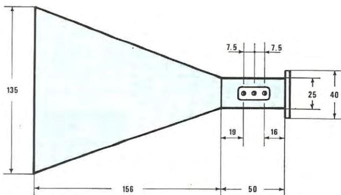
Fig. 1 Di lato il disegno con le quote necessarie per chi desidera autocostruirsi l'antenna a tromba piramidale da 20 dB di guadagno. In basso la foto dell'antenna come si presenta una volta realizzata.
