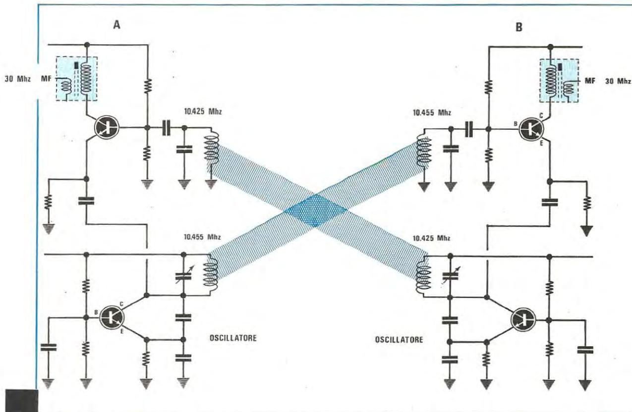
Fig. 5 In questo disegno abbiamo ipoteticamente paragonato la nostra cavità ad un circuito supereterodina composto da un transistor amplificatore AF-Convertitor e da un transistor Oscillatore Locale.
