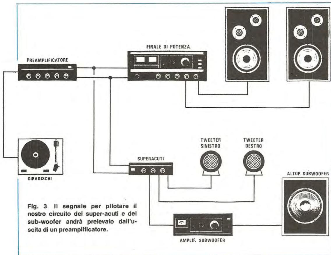
Fig. 3 Il segnale per pilotare il nostro circuito dei super-acuti e del sub-woofer andrà prelevato dall'uscita di un preamplificatore.
