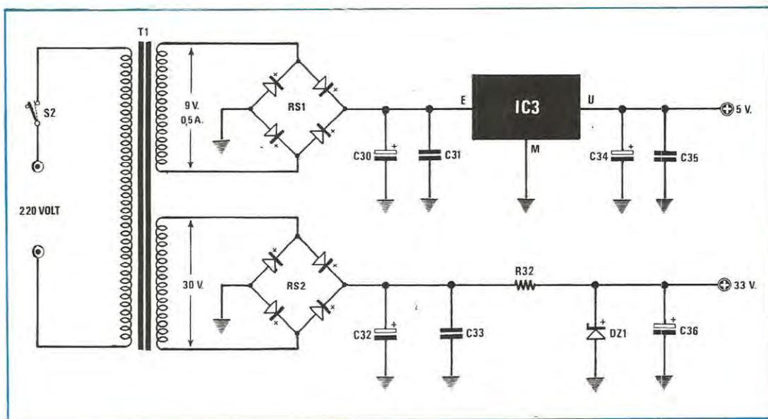
**Fig. 2** Schema elettrico dello stadio alimentatore incluso sullo stesso circuito stampato dell'oscillatore AF. Per la lista componenti vedere a pag. 363 di fianco allo schema elettrico dell'oscillatore.
