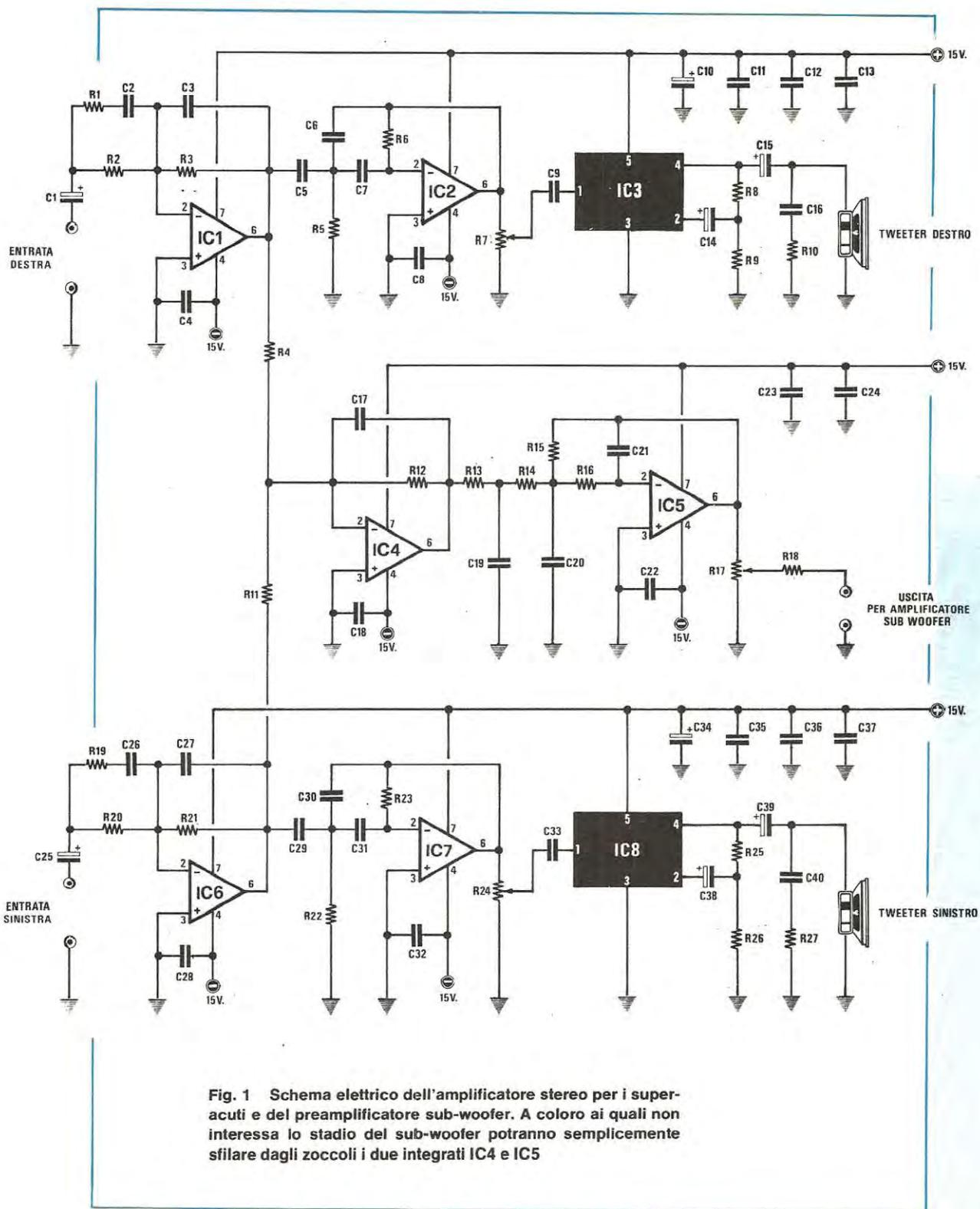
Fig. 1 Schema elettrico dell'amplificatore stereo per i super-acuti e del preamplificatore sub-woofer. A coloro ai quali non interessa lo stadio del sub-woofer potranno semplicemente sfilare dagli zoccoli i due integrati IC4 e IC5
