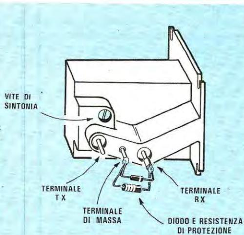
**Fig. 3** Dalla cavità escono tre terminali, quello di sinistra, indicato con TX, è relativo al diodo gunn, il centrale è la massa e quello di destra è relativo al diodo Schottky (cioè al ricevitore). Si notino la resistenza e il diodo di protezione applicati tra il terminale di massa e il terminale RX.
