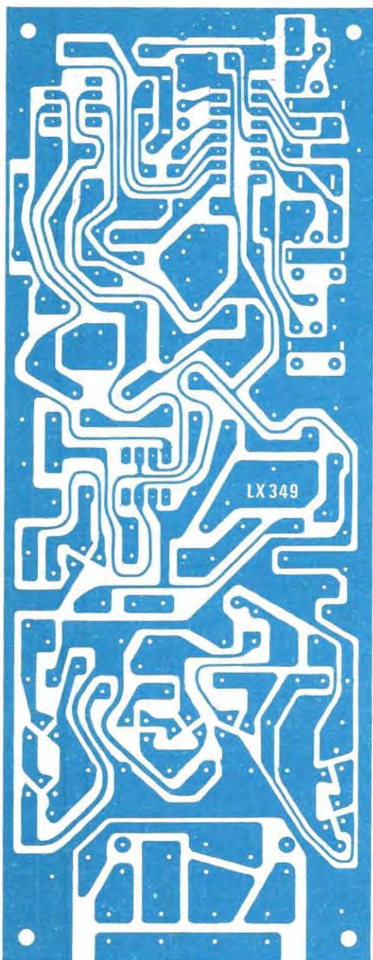
**Fig. 2** Disegno a grandezza naturale del circuito stampato necessario per la realizzazione del ricevitore per radiocomando a tre canali. Come vedesi nella figura della pagina accanto, su questo circuito vengono fissati pure i tre relè che sfrutteremo per fornire tensione ai motorini o ad altri servorelè.
