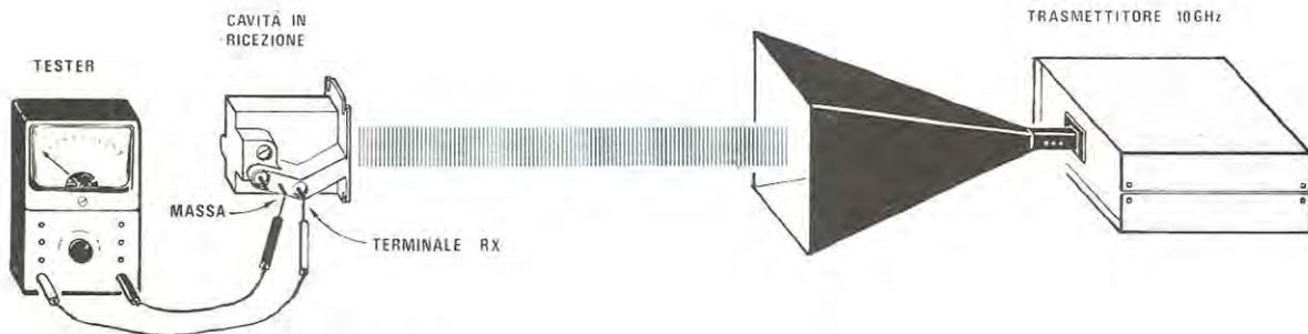
**Fig. 5** Se avete a disposizione una seconda cavità vi sarà molto facile poter tarare l'antenna, inserendo in uno dei tre fori una vite come spiegato nell'articolo. Infatti questa seconda cavità la useremo come « ricevente » misurando la corrente tra il terminale RX e la massa (leggere l'articolo attentamente).
