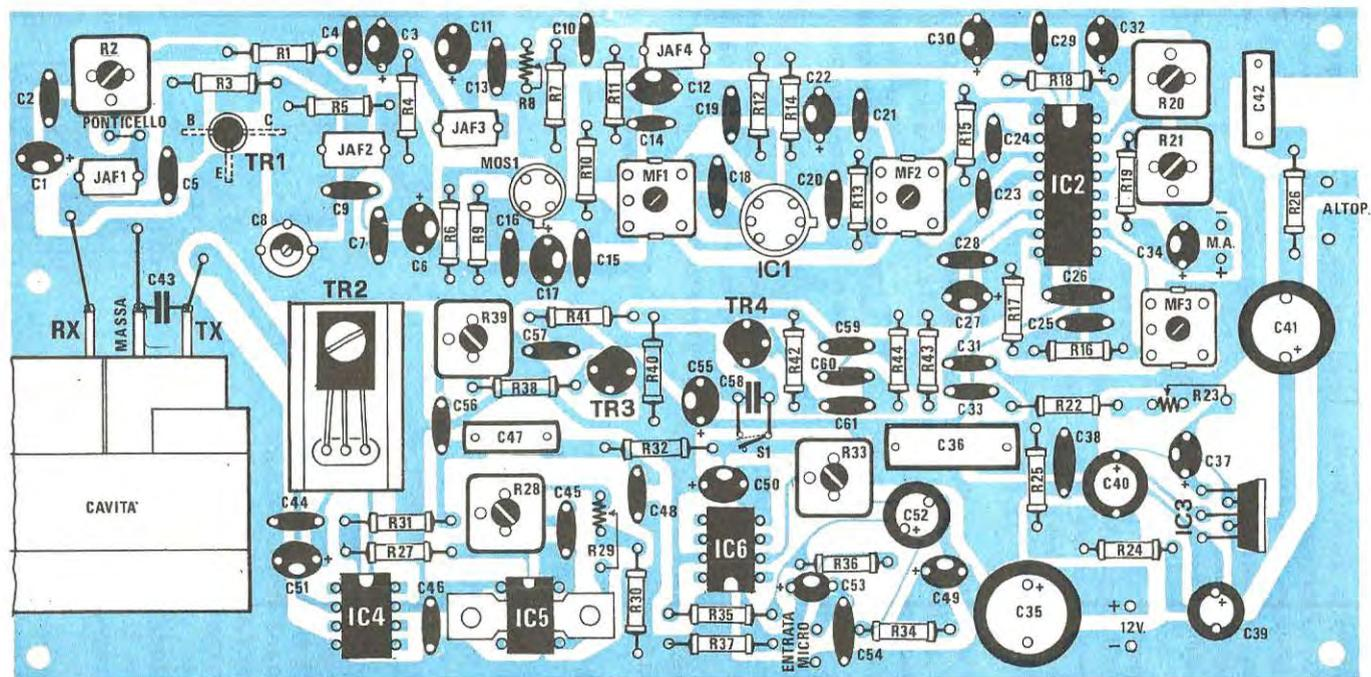
Fig. 5 Disegno serigrafico presente sul circuito stampato che qui eccezionalmente riportiamo in quanto potrà meglio dello schema pratico di fig. 6 farvi vedere la posizione in cui debbono essere collocati i vari componenti.
