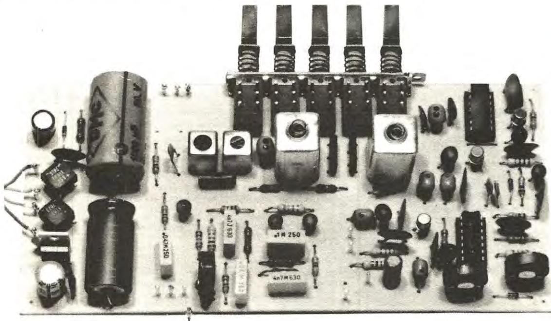
**Come si presenta a realizzazione ultimata l'oscillatore di AF descritto nell'articolo. Si notino le quattro bobine complete di schermo poste in prossimità del commutatore a slitta, e sulla sinistra i due ponti raddrizzatori che collegheremo ai secondari del trasformatore come indicato in fig. 2.**
