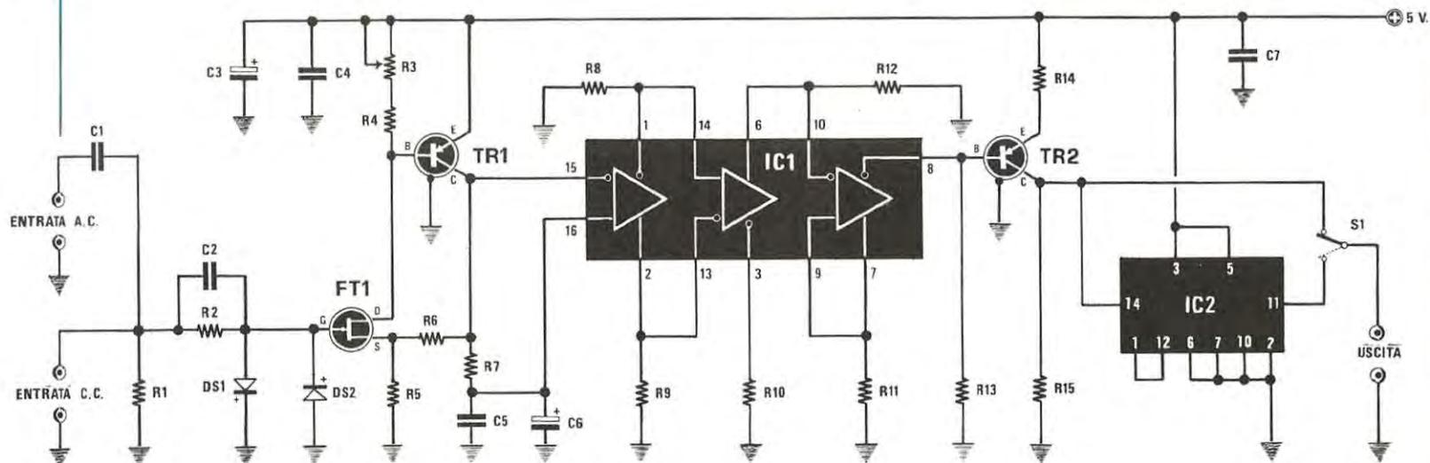
Fig. 1 Schema elettrico del preamplificatore digitale da 50-60 Megahertz completo di divisore X 10 per renderlo idoneo a pilotare dei telai a C-Mos.
