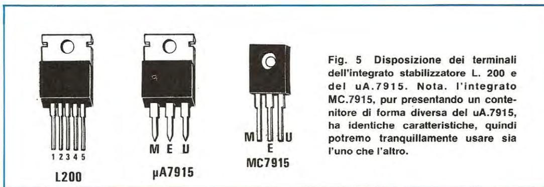
terminale negativo è collegato all'ingresso di un secondo integrato stabilizzatore di tipo uA.7915 (vedi IC2) il quale, come ormai saprete, può erogare fino ad un massimo di 0,8-1 ampère.
