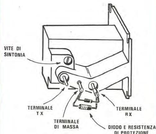
**Fig. 3** Vi ricordiamo che la vite posta sopra al terminale TX è quella di sintonia, e nuovamente ci raccomandiamo di non stagnare alcun filo sul terminale RX. Il filo che va a questo terminale dovremo stagnarlo al tubettino in esso inserito solo dopo averlo sfilato come vedesi in figura.
