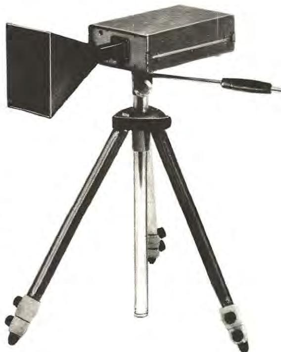
Foto di un nostro ricetrasmittitore completo di antenna a tromba piramidale da 20 dB, montato su un cavalletto per poter meglio direzionare l'antenna sul punto prestabilito.
