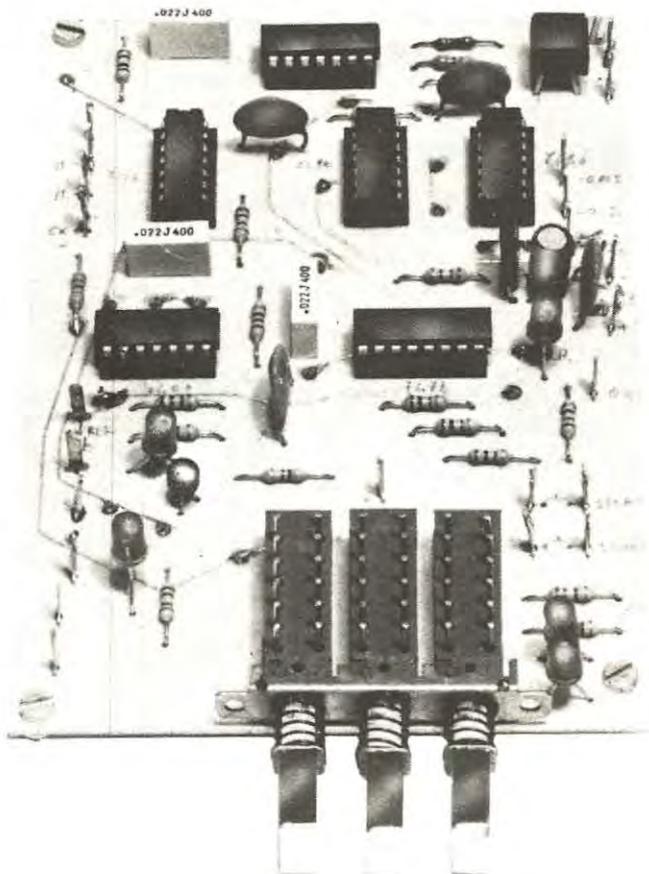
A costruzione ultimata il nostro montaggio risulterà identico a quello visibile in queste foto. Si noti il triplo commutatore a tastiera inserito direttamente sul circuito stampato.
