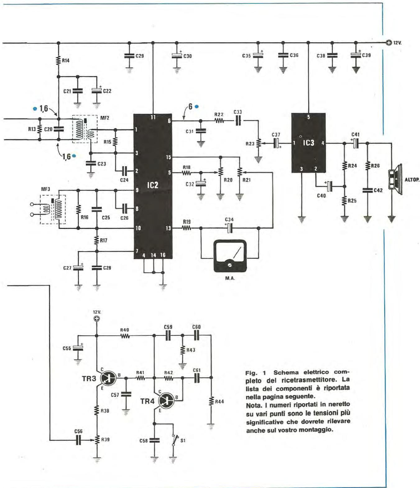
Fig. 1 Schema elettrico completo del ricetrasmettitore. La lista dei componenti è riportata nella pagina seguente. Nota. I numeri riportati in neretto su vari punti sono le tensioni più significative che dovrete rilevare anche sul vostro montaggio.
