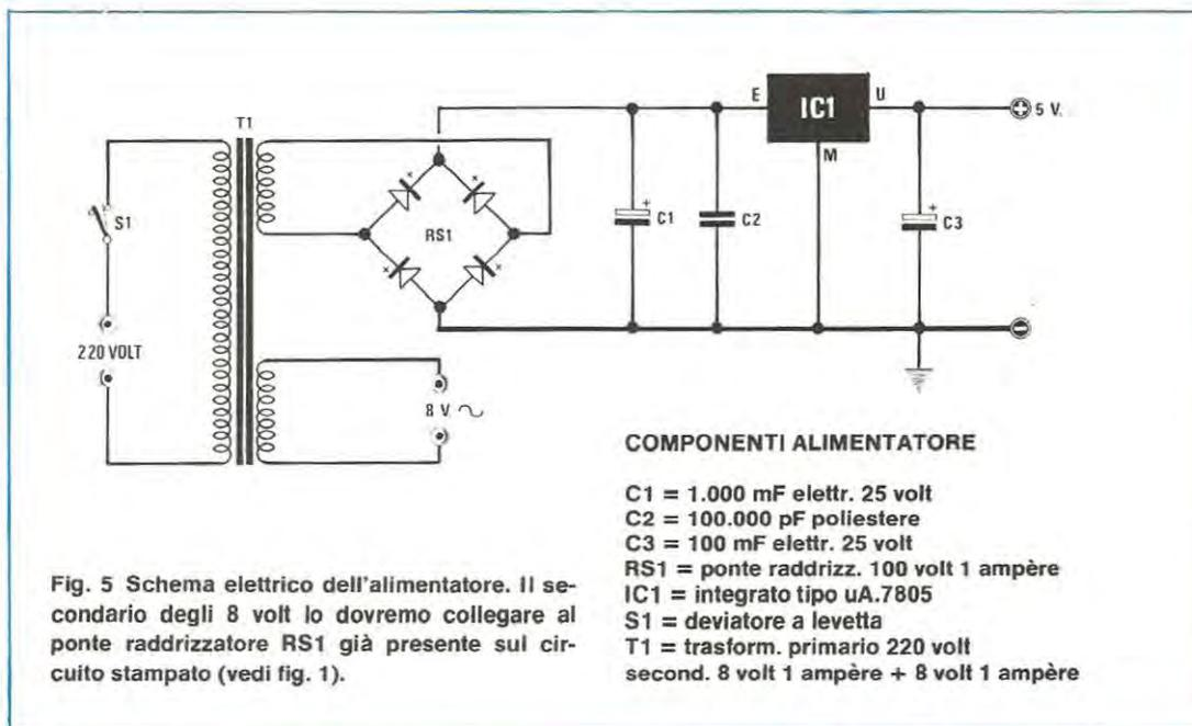
Fig. 5 Schema elettrico dell'alimentatore. Il secondario degli 8 volt lo dovremo collegare al ponte raddrizzatore RS1 già presente sul circuito stampato (vedi fig. 1).
