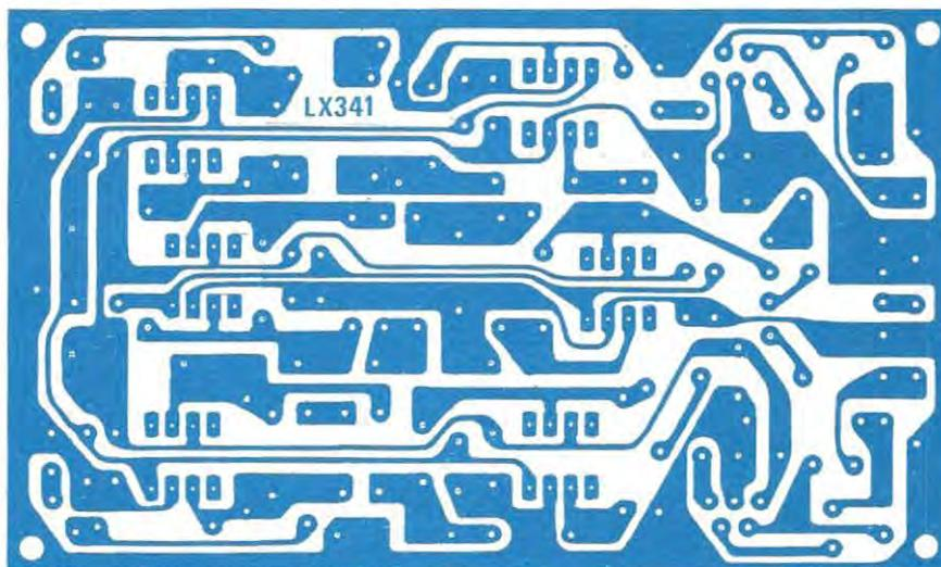
**Fig. 7** Circuito stampato a grandezza naturale siglato LX.341 necessario per la realizzazione del progetto descritto nell'articolo. Il circuito viene fornito già forato e completo di disegno serigrafico.
