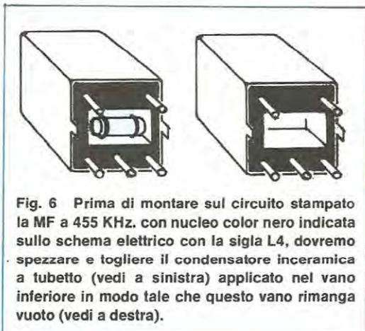
**Fig. 6** Prima di montare sul circuito stampato la MF a 455 KHz. con nucleo color nero indicata sullo schema elettrico con la sigla L4, dovremo spezzare e togliere il condensatore inceramica a tubetto (vedi a sinistra) applicato nel vano inferiore in modo tale che questo vano rimanga vuoto (vedi a destra).
