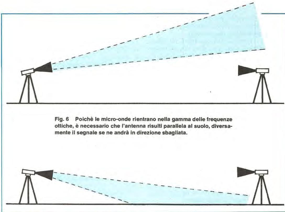
**Fig. 6** Poiché le micro-onde rientrano nella gamma delle frequenze ottiche, è necessario che l'antenna risulti parallela al suolo, diversamente il segnale se ne andrà in direzione sbagliata.
