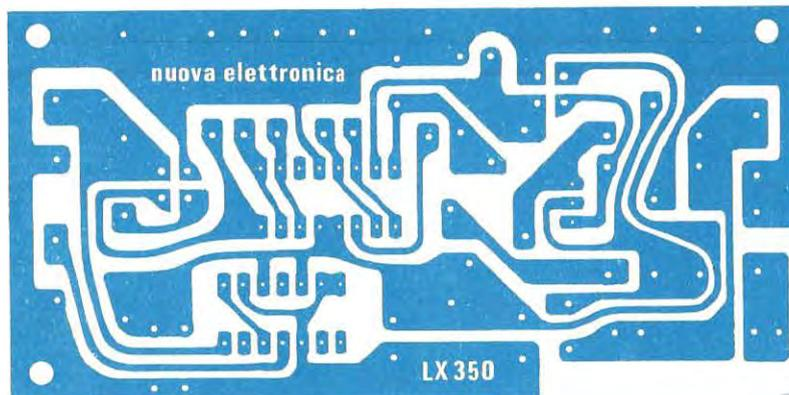
Fig. 3 Disegno a grandezza naturale del circuito stampato necessario alla realizzazione del preamplificatore digitale.
