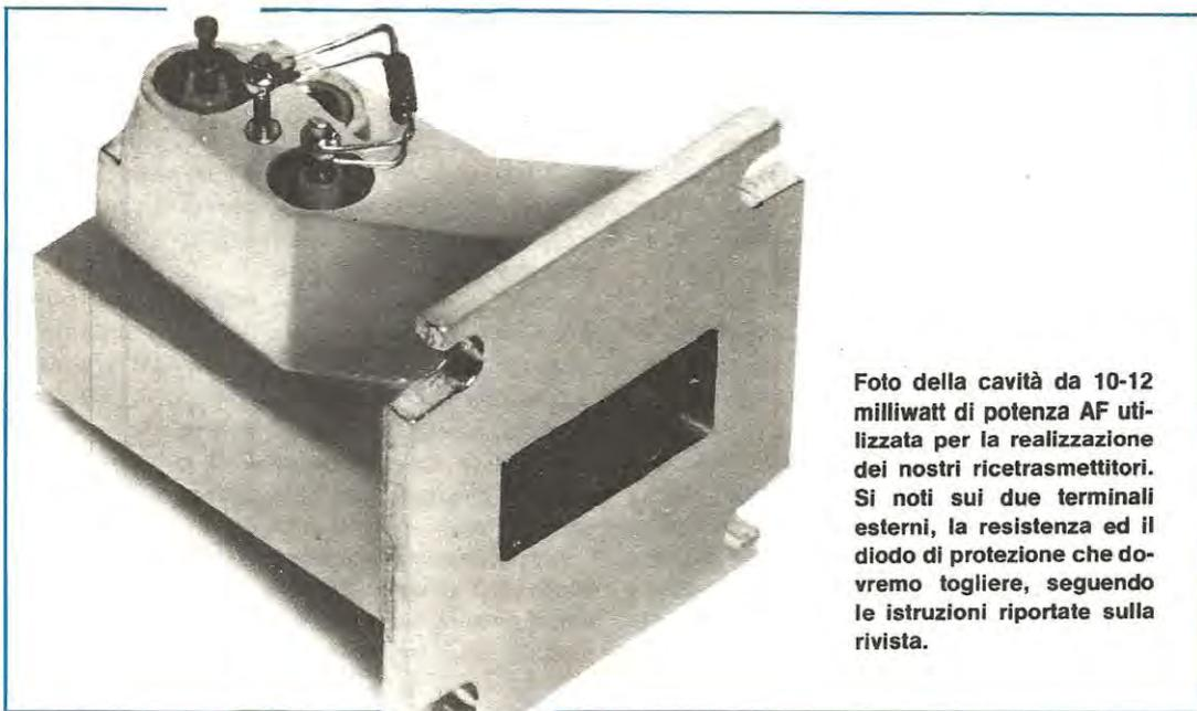
Foto della cavità da 10-12 milliwatt di potenza AF utilizzata per la realizzazione dei nostri ricetrasmittitori. Si noti sui due terminali esterni, la resistenza ed il diodo di protezione che dovremo togliere, seguendo le istruzioni riportate sulla rivista.
