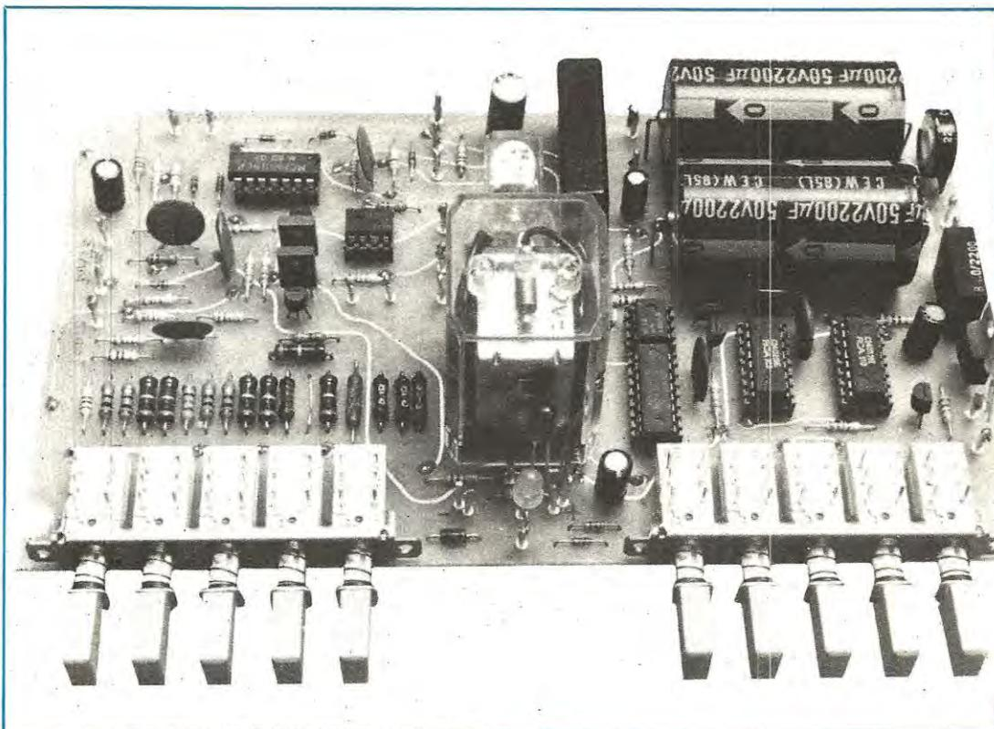
In questa foto potete vedere un circuito già montato. Si notino i commutatori a slitta, il relè 2 e sulla destra in alto lo stadio alimentatore. **NOTA:** i diodi led saldati sui terminali del circuito stampato andranno fissati sul pannello frontale del mobile.
