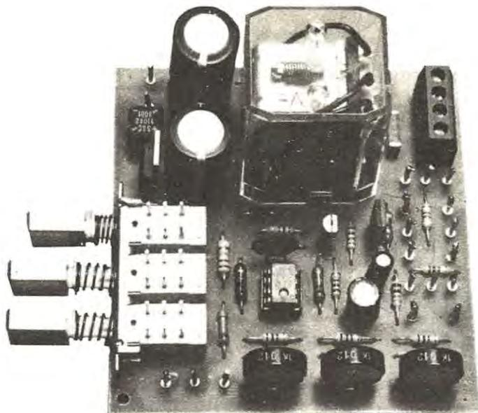
Il circuito, una volta terminato il montaggio, si presenterà come vedesi in questa foto. Si noti sulla sinistra il commutatore a slitta necessario per selezionare le tre sensibilità, il relè di potenza e in alto a destra la morsettierà per i fili da congiungere all'ingranditore.
