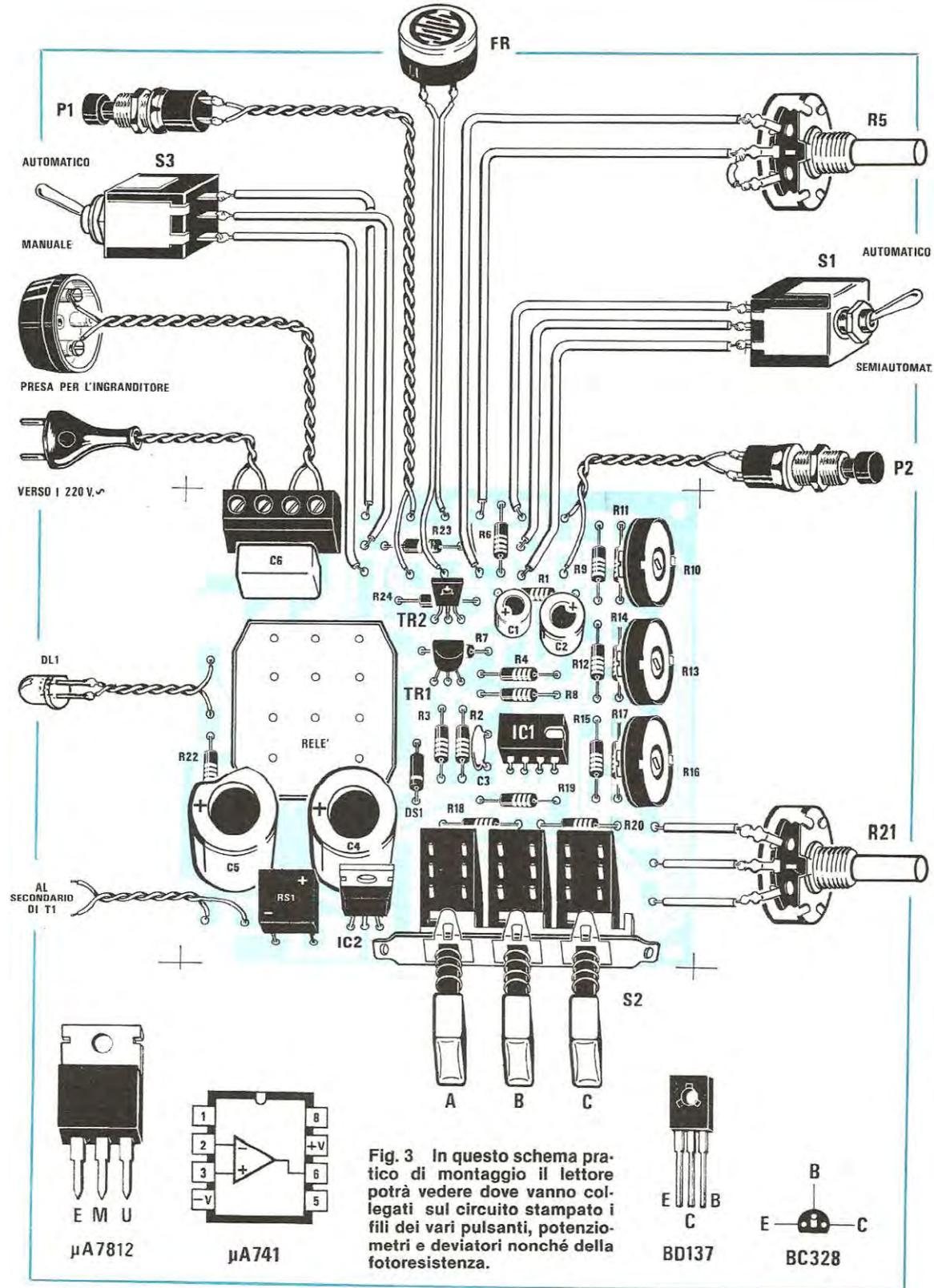
Fig. 3 In questo schema pratico di montaggio il lettore potrà vedere dove vanno collegati sul circuito stampato i fili dei vari pulsanti, potenziometri e deviatori nonché della fotoresistenza.
