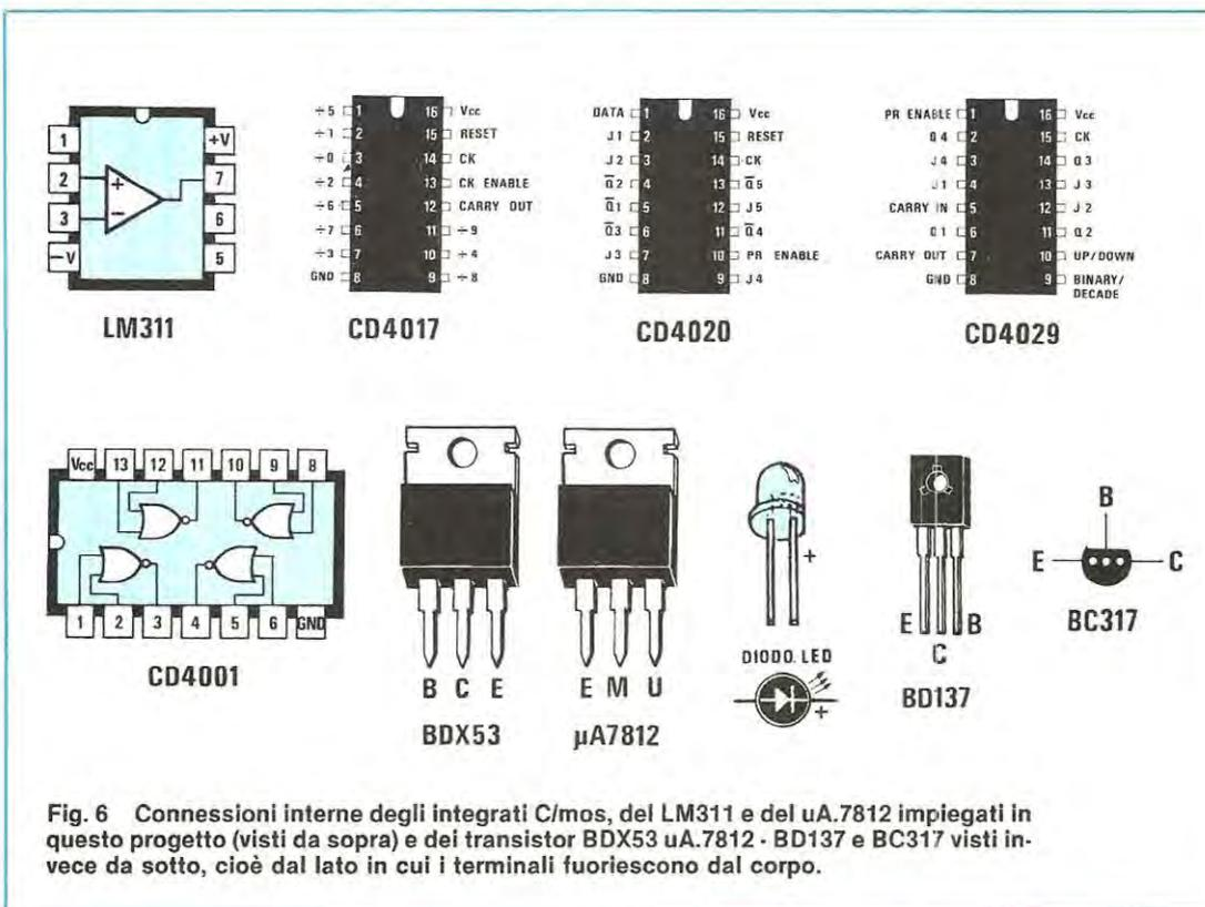
Fig. 6 Connessioni interne degli integrati C/mos, del LM311 e del  $\mu A.7812$  impiegati in questo progetto (visti da sopra) e dei transistor BDX53 -  $\mu A.7812$  - BD137 e BC317 visti invece da sotto, cioè dal lato in cui i terminali fuoriescono dal corpo.
