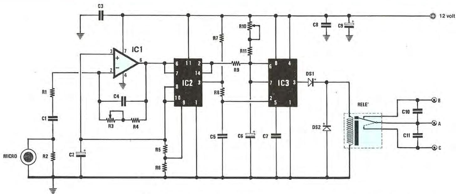
Fig. 1 Schema elettrico del relè fonico e connessioni degli integrati impiegati per tale realizzazione. Il microfono da impiegare dovrà essere del tipo piezoelettrico perché quelli dinamici non dispongono della necessaria sensibilità.
