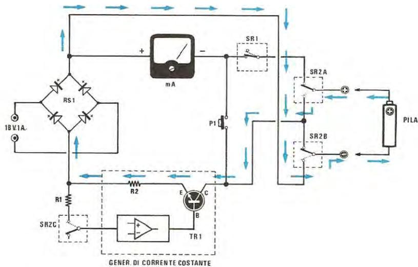
**Fig. 2** Una pila al nichel-cadmio, prima di essere ricaricata, dovrà essere totalmente scaricata per neutralizzare l'effetto memoria. Nel nostro circuito questo avviene automaticamente non solo, ma il generatore di corrente costante provvederà a scaricarle con una corrente 10 volte maggiore rispetto a quella di ricarica.
