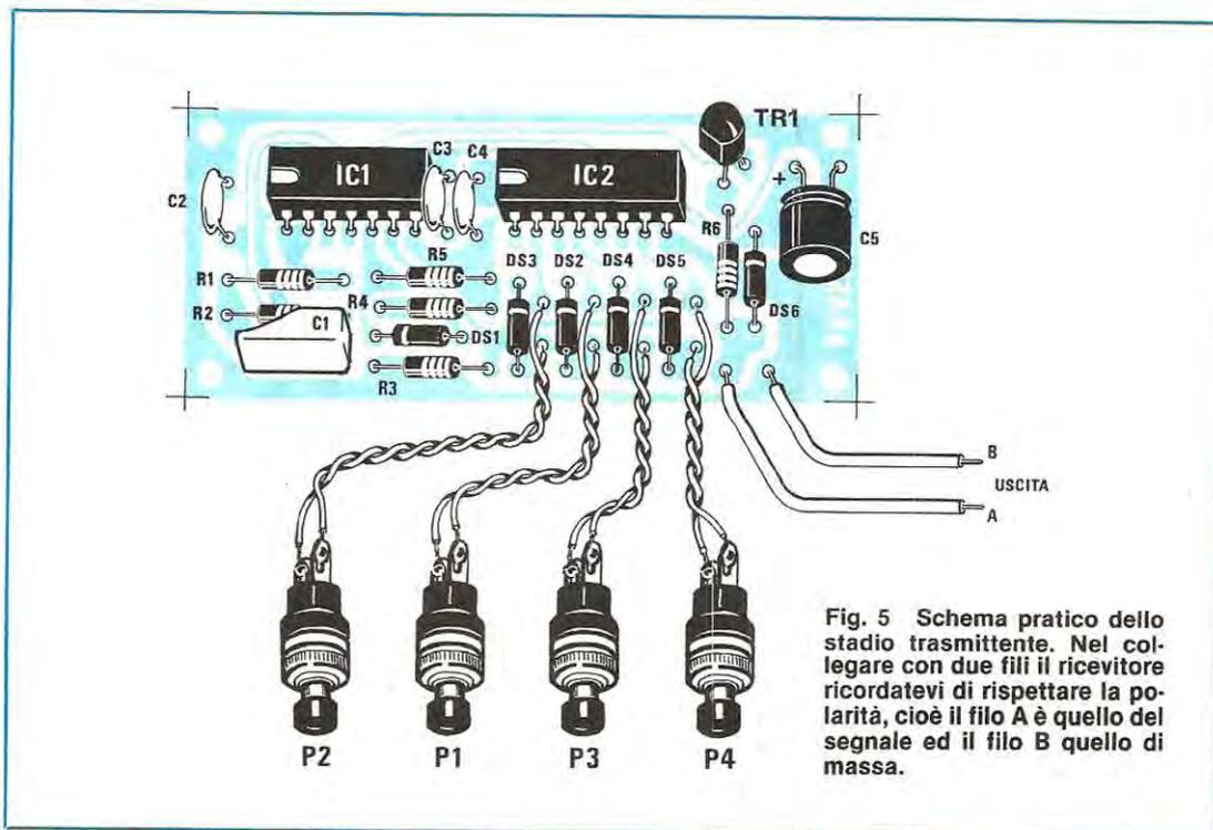
Fig. 5 Schema pratico dello stadio trasmettente. Nel collegare con due fili il ricevitore ricordatevi di rispettare la polarità, cioè il filo A è quello del segnale ed il filo B quello di massa.
