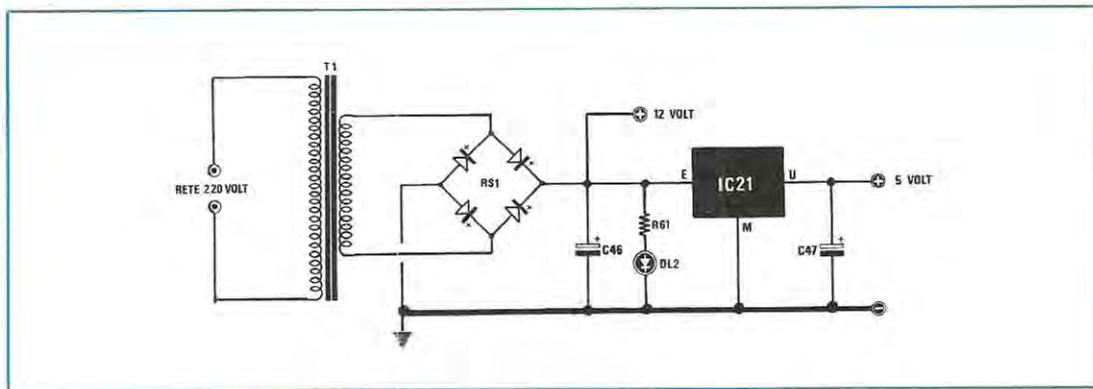
**Fig. 2** Schema elettrico dell'alimentatore i cui componenti troveranno alloggio sul circuito stampato sulla destra del relé n. 2. La lista dei componenti è riportata insieme a quella dello schema elettrico generale della fig. 1.
