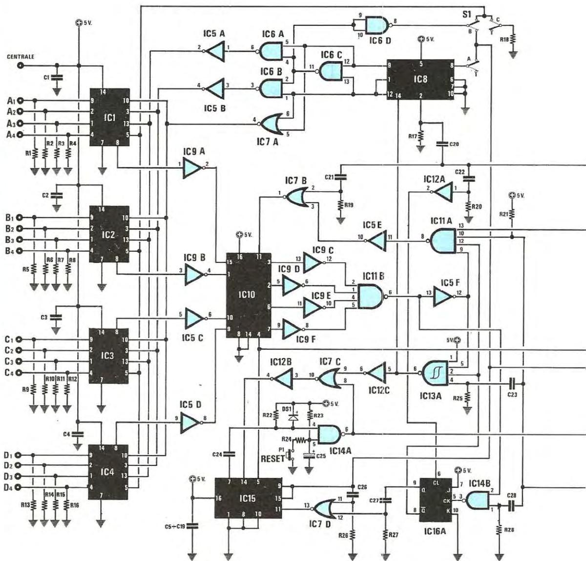
Fig. 1/A Questo è lo schema elettrico completo del circuito descritto nell'articolo. Tale schema a prima vista può risultare molto complesso in quanto noi, per facilitarne la lettura, abbiamo tenuto separati i vari inverter, nand, nor contenuti nell'interno di un solo integrato tuttavia in pratica, come vedesi in fig. 4, la realizzazione risulta molto più semplice.
