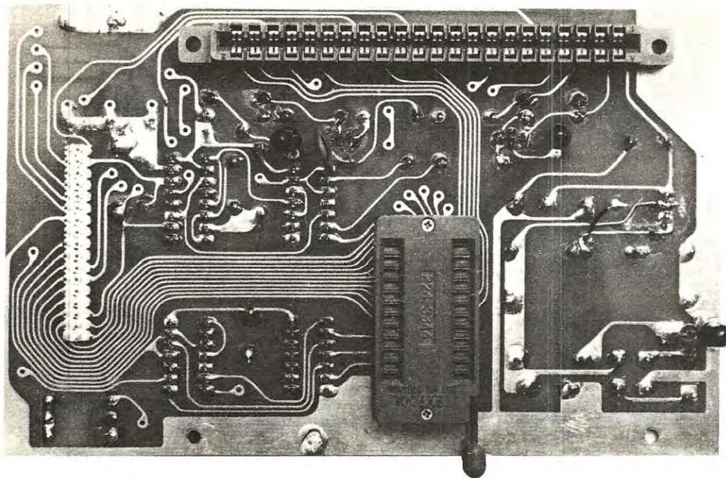
un diverso metodo di programmazione, anche perché da Eprom a Eprom cambia la disposizione dei terminali, quindi un programmatore costruito ad esempio per la 2708 non potrà andare bene per la 2716 o la 2532 le quali, rispetto alla 2708, sono totalmente diverse come costituzione.
