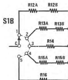
**Fig. 5** Quanto detto sopra per il commutatore S1/A vale anche per il commutatore S1/B infatti anche qui sul circuito stampato troveremo R12A-R12B R13A-R13B R14A-R14B mentre nello schema elettrico queste resistenze non appaiono: i valori ohmmici di R12-R13-R14 vengono infatti ottenuti, come vedesi in questo disegno, collegando due resistenze in serie.
