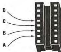
Fig. 9 Sullo zoccolo estraibile noi dovremo aprire tutti i ponticelli in cortocircuito eccetto uno «solo». Per il primo drive, lasceremo in corto il ponticello A. Usando due floppy, sul secondo lasceremo in corto il ponticello B, usandone tre sul terzo lasceremo in corto il solo ponticello C, mentre usandone quattro l'ultimo avrà in corto il ponticello D. In pratica il primo floppy si chiamerà A oppure 0, il secondo B o 1, il terzo C o 2, il quarto D o 3.
