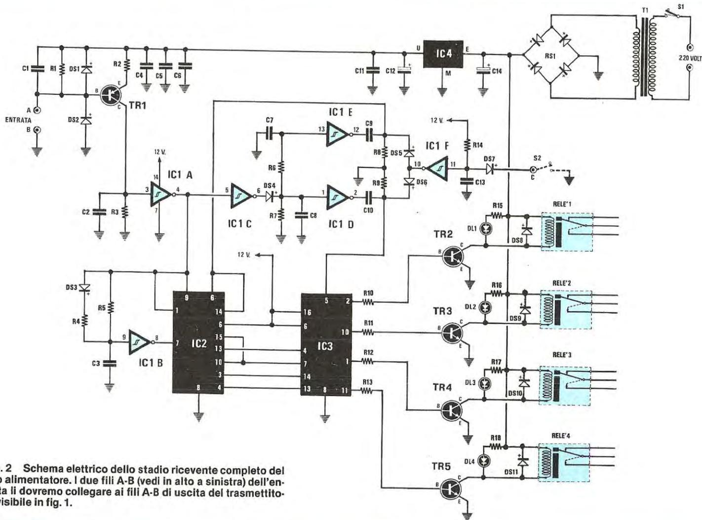
Fig. 2 Schema elettrico dello stadio ricevente completo del suo alimentatore. I due fili A-B (vedi in alto a sinistra) dell'entrata li dovremo collegare ai fili A-B di uscita del trasmettitore visibile in fig. 1.
