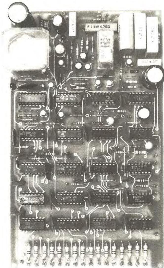
In questa foto possiamo vedere un prototipo montato dell'automatismo in grado di comandare a distanza tramite una linea telefonica qualsiasi apparecchiatura radio elettrica. Si notino in alto i due relè (a sinistra quello di potenza) ed in basso i terminali a cui collegheremo i commutatori Contraves necessari per ottenere la combinazione chiave per l'accesso al nostro circuito.
