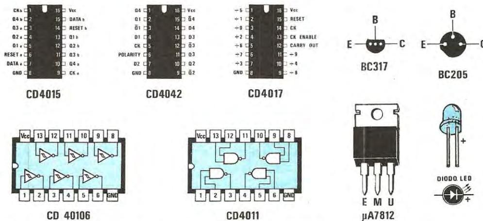
Fig. 4 Connessioni degli integrati C/mos impiegati in questo progetto visti da sopra e dei transistor visti invece da sotto, cioè dal lato in cui i terminali fuoriescono dall'involucro.
