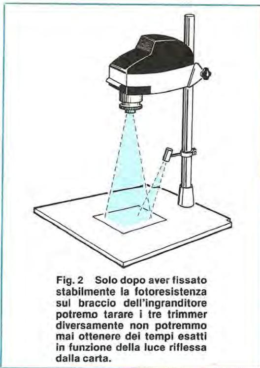
**Fig. 2 Solo dopo aver fissato stabilmente la fotoresistenza sul braccio dell'ingranditore potremo tarare i tre trimmer diversamente non potremo mai ottenere dei tempi esatti in funzione della luce riflessa dalla carta.**
