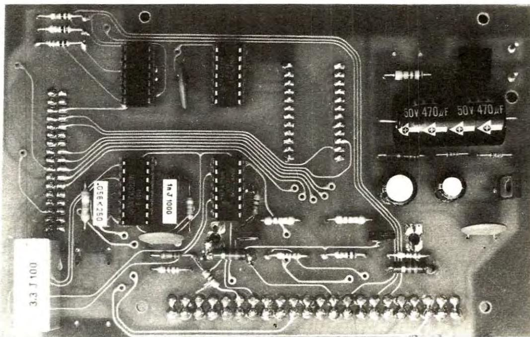
**Foto in alto a sinistra - Nell'interno del mobile visibile nella pagina precedente dovremo fissare il circuito stampato LX395. Sulla parte superiore di questo (trattasi di una doppia faccia a fori metallizzati) andrà stagnato il connettore necessario per ricevere le schede di programmazione relative a vari tipi di Eprom, lo zoccolo Textool ed il connettore maschio per la piastrina che ci permetterà di collegarci elettricamente alla scheda LX394 inserita nel bus del micro-computer.**
