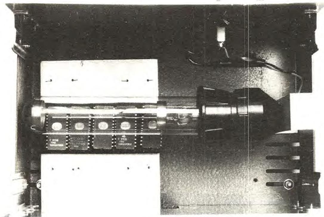
**Fig. 2** Inserendo le Eprom nell'interno del mobile dovrete fare in modo che le finestrelle presenti al centro del corpo vengano a trovarsi esattamente sotto il bulbo della lampada, diversamente occorrerà un tempo maggiore per ottenere una cancellazione totale. È pure consigliabile pulire tale finestrella con un batuffolo di cotone imbevuto nell'alcool.
