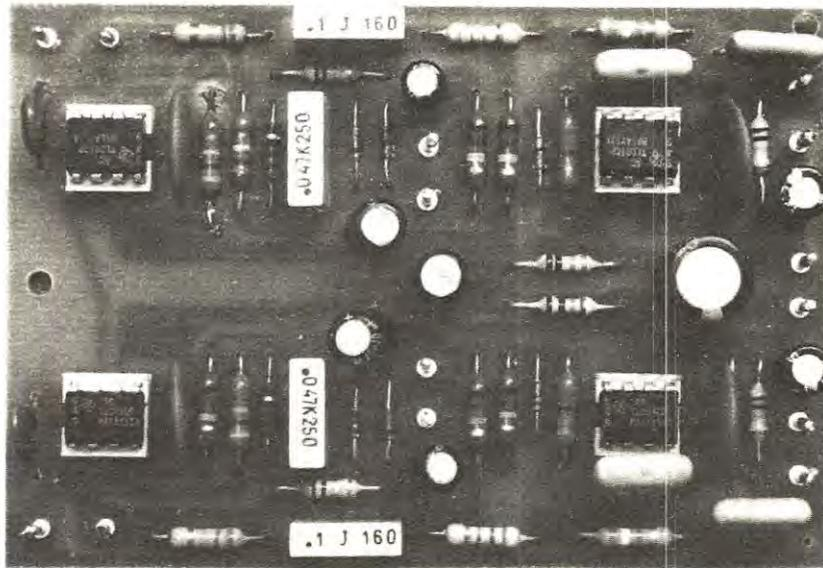
**Fig. 6** Il circuito che noi monteremo è in versione stereo, cioè lo schema di fig. 5 è riportato sullo stampato due volte, in modo tale da poter agire sia sul canale di destra che di sinistra. Nella foto possiamo vedere come si presenta tale circuito una volta montato. Per evitare che questo accessorio capti ed introduca nell'amplificatore del ronzio di alternata, si consiglia di racchiudere il tutto entro una scatola metallica e di impiegare per l'ingresso e l'uscita del cavetto schermato.
