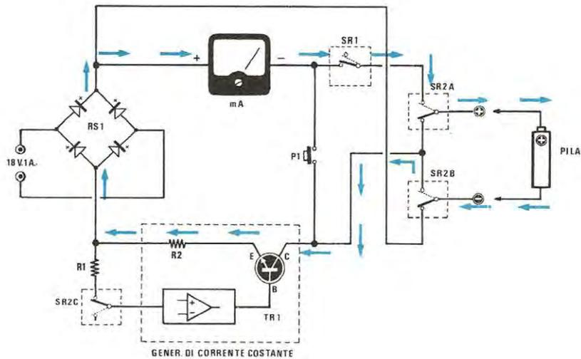
**Fig. 1** In fase di ricarica i contatti del relè 2 forniranno alla pila una corrente costante da noi precedentemente determinata (piangiando il pulsante P1) in funzione delle caratteristiche della pila e del tempo richiesto per la carica. Lo strumento inserito ci permetterà di controllare dall'inizio alla fine la corrente erogata dal nostro alimentatore.
