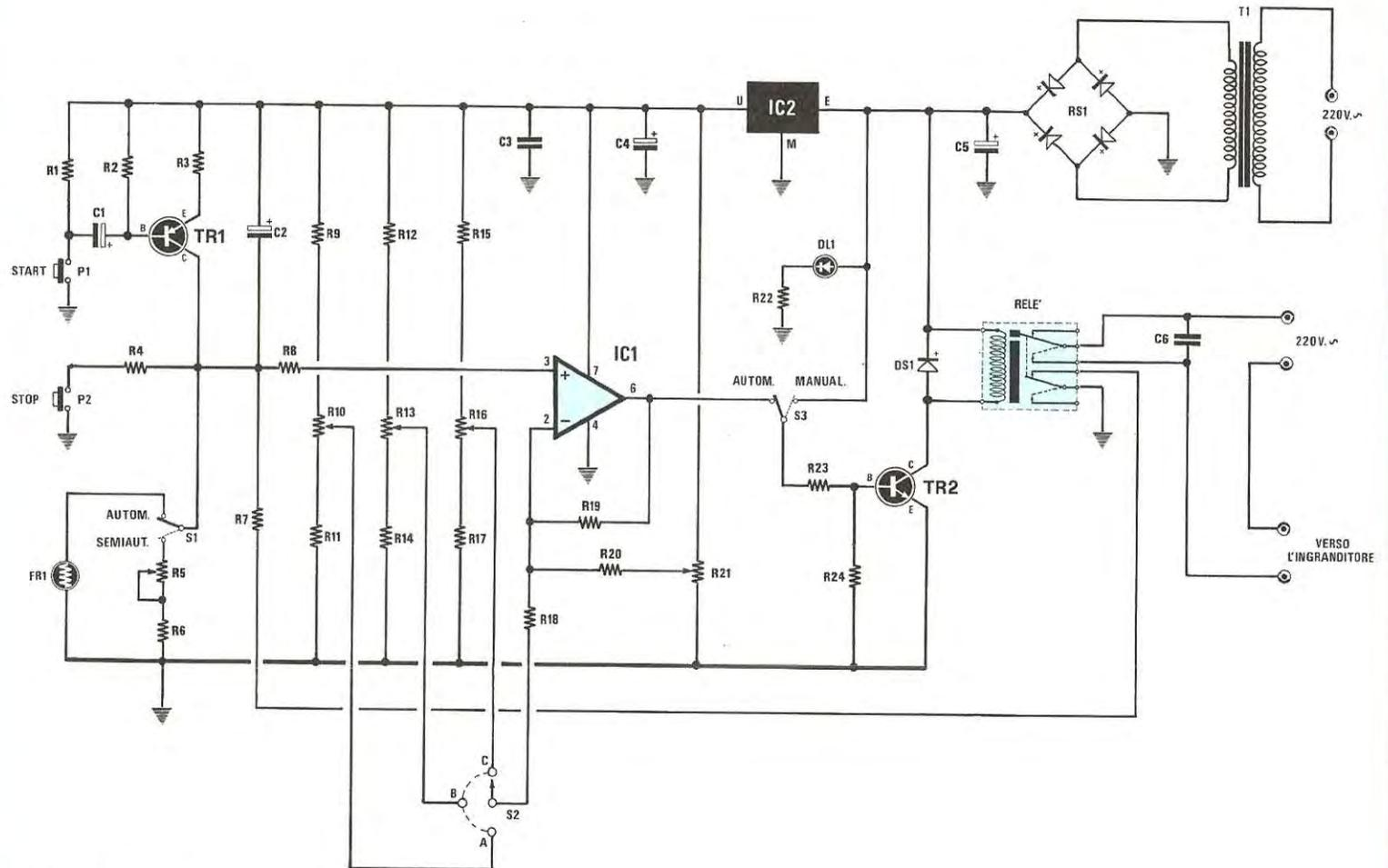
Fig. 1 Schema elettrico
