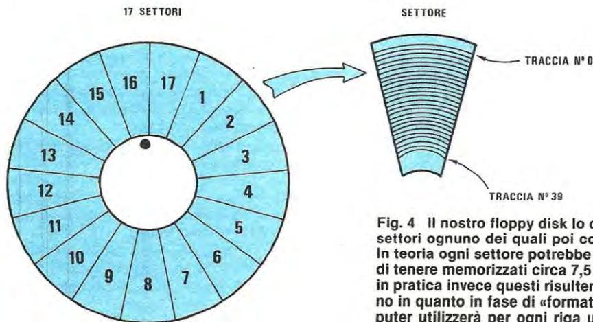
Fig. 4 Il nostro floppy disk lo divideremo in 17 settori ognuno dei quali poi conterrà 40 righe. In teoria ogni settore potrebbe essere in grado di tenere memorizzati circa 7,5 kilobyte di dati: in pratica invece questi risulteranno molto meno in quanto in fase di «formattazione» il computer utilizzerà per ogni riga un po' di spazio per inserirvi i dati necessari ad individuare l'inizio e la fine di ogni settore.
