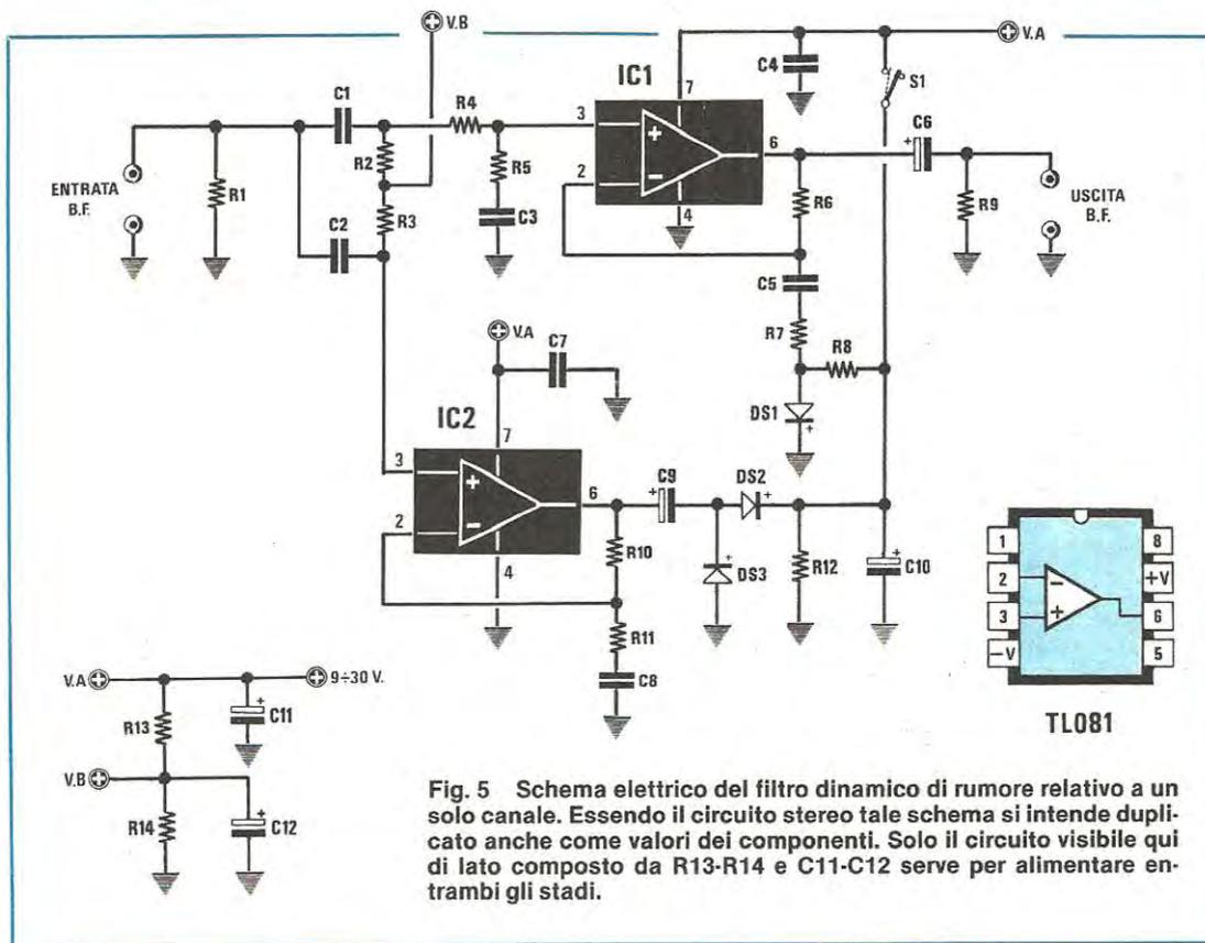
Fig. 5 Schema elettrico del filtro dinamico di rumore relativo a un solo canale. Essendo il circuito stereo tale schema si intende duplicato anche come valori dei componenti. Solo il circuito visibile qui di lato composto da R13-R14 e C11-C12 serve per alimentare entrambi gli stadi.
