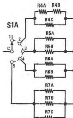
**Fig. 4** Nella lista componenti troviamo la resistenza R4A-R4B-R4C poi R5A-R5B - R6A-R6B e R7A-R7B-R7C mentre nello schema elettrico di fig. 3 vediamo riportata una sola resistenza per ciascuna sigla. Il motivo è qui svelato, infatti per ottenere il valore ohmmico richiesto per ogni portata è necessario, come vedesi in questo disegno, effettuare delle serie parallelo con resistenze di valore standard.
