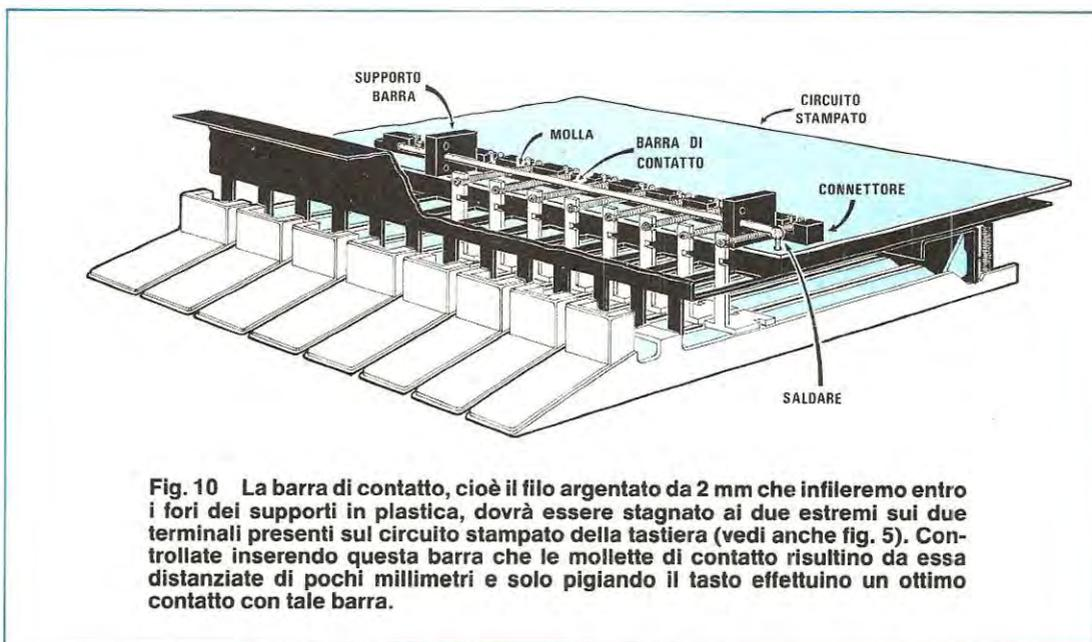
**Fig. 10** La barra di contatto, cioè il filo argentato da 2 mm che infileremo entro i fori dei supporti in plastica, dovrà essere stagnato ai due estremi sui due terminali presenti sul circuito stampato della tastiera (vedi anche fig. 5). Controllate inserendo questa barra che le mollette di contatto risultino da essa distanziate di pochi millimetri e solo pigiando il tasto effettuino un ottimo contatto con tale barra.
