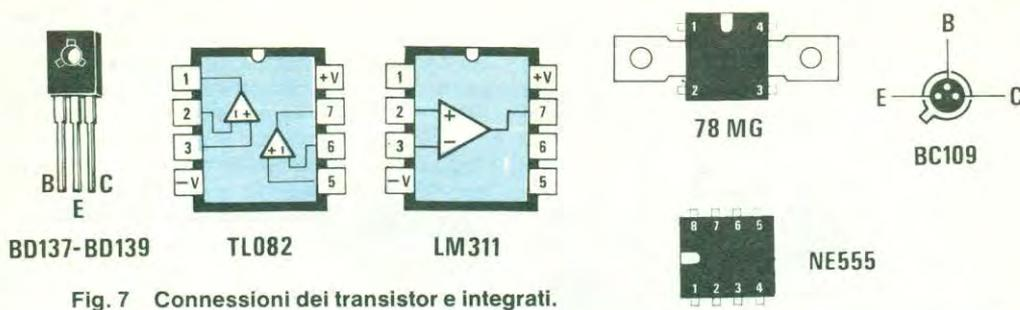
Fig. 7 Connessioni dei transistor e integrati.
