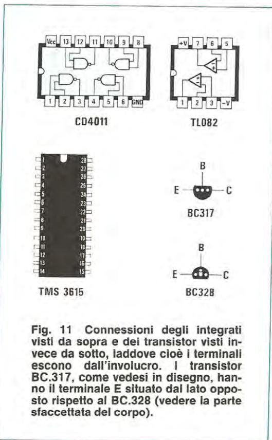
**Fig. 11** Connessioni degli integrati visti da sopra e dei transistor visti invece da sotto, laddove cioè i terminali escono dall'involucro. I transistor BC.317, come vedesi in disegno, hanno il terminale E situato dal lato opposto rispetto al BC.328 (vedere la parte sfaccettata del corpo).
