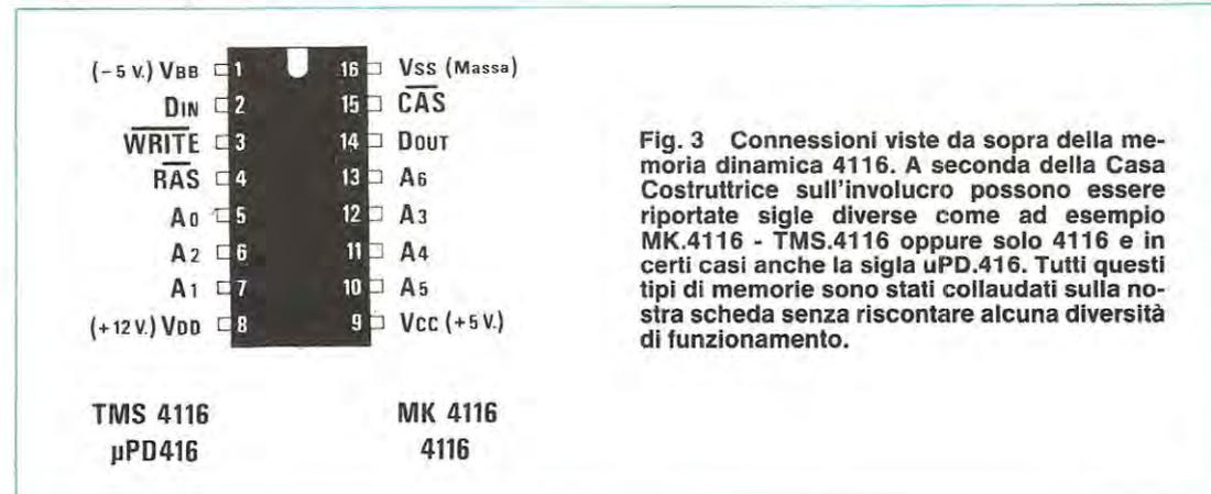
Fig. 3 Connessioni viste da sopra della memoria dinamica 4116. A seconda della Casa Costruttrice sull'involucro possono essere riportate sigle diverse come ad esempio MK.4116 - TMS.4116 oppure solo 4116 e in certi casi anche la sigla uPD.4116. Tutti questi tipi di memorie sono stati collaudati sulla nostra scheda senza riscontare alcuna diversità di funzionamento.
