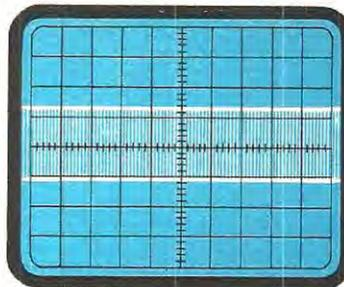
**Fig. 4** In assenza di modulazione un segnale di AF apparirà sullo schermo dell'oscilloscopio come una fascia luminosa. Tarando i compensatori del trasmettitore se questi risultano starati la fascia si allargherà, diversamente si restringerà.
