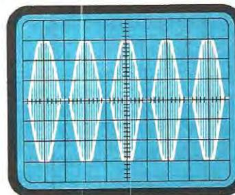
**Fig. 3** Quando si sovramodula un segnale di AF, gli estremi superiori ed inferiori di detto segnale risultano squadrati ed al centro la separazione tra le due semionde è molto netta. Tale condizione provoca un'elevata distorsione sul segnale di BF e per eliminarla è necessario abbassare il volume.
