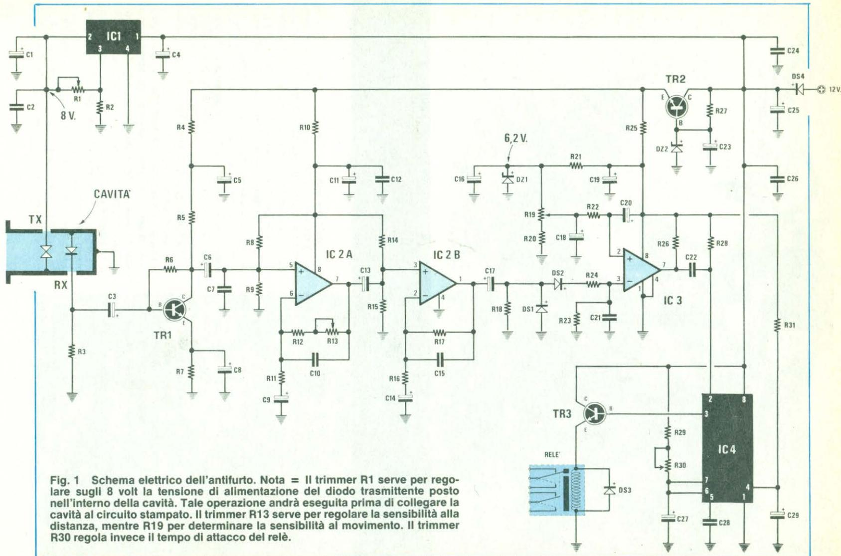
Fig. 1 Schema elettrico dell'antifurto. Nota = Il trimmer R1 serve per regolare sugli 8 volt la tensione di alimentazione del diodo trasmettente posto nell'interno della cavità. Tale operazione andrà eseguita prima di collegare la cavità al circuito stampato. Il trimmer R13 serve per regolare la sensibilità alla distanza, mentre R19 per determinare la sensibilità al movimento. Il trimmer R30 regola invece il tempo di attacco del relè.
