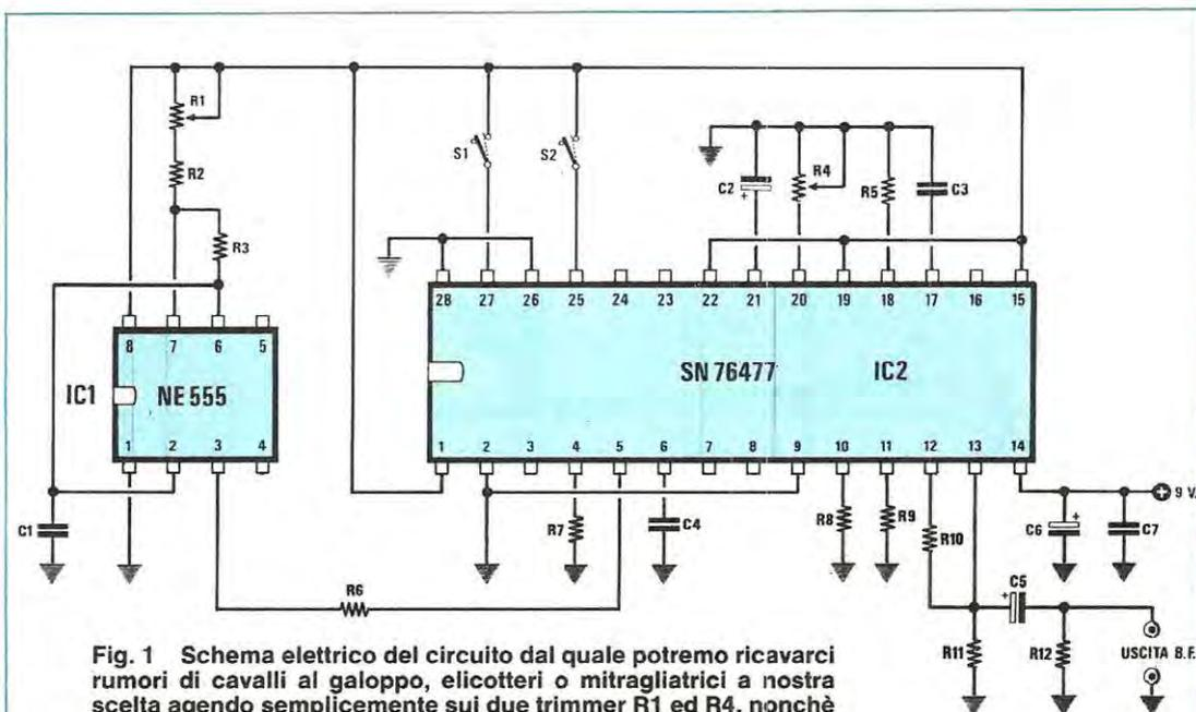
Fig. 1 Schema elettrico del circuito dal quale potremo ricavarci rumori di cavalli al galoppo, elicotteri o mitragliatrici a nostra scelta agendo semplicemente sui due trimmer R1 ed R4, nonché sui deviatori S1-S2.
