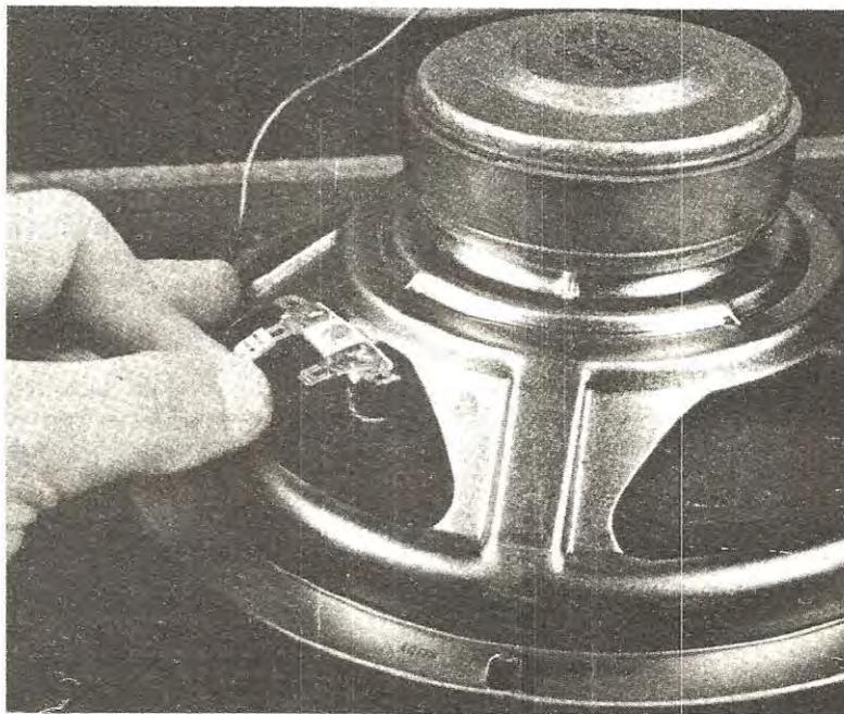
**Applicate sui due terminali dell'altoparlante i coccodrilli del nostro circuito e subito potrete leggere sullo strumento l'impedenza della bobina mobile.**
