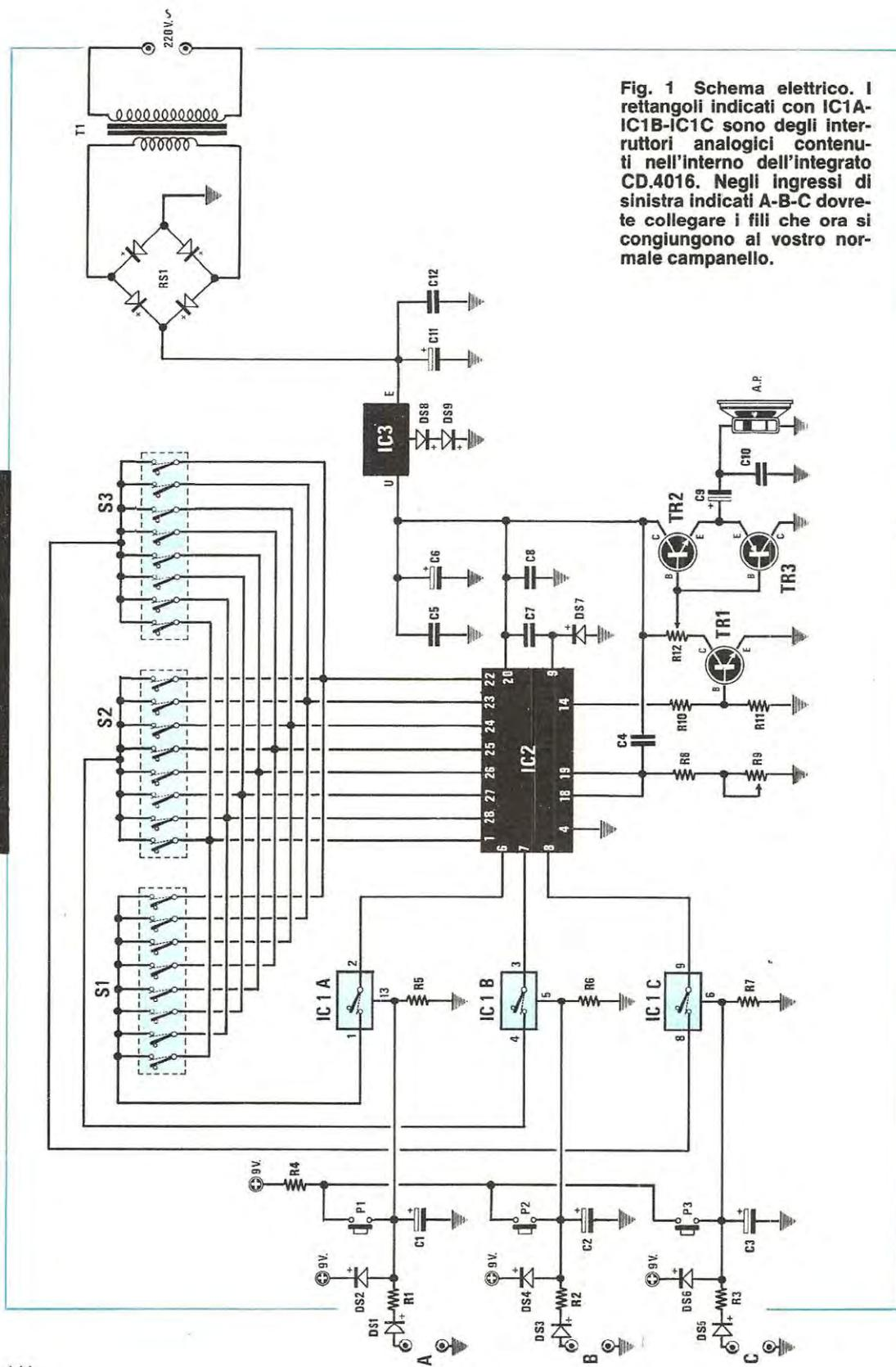
Fig. 1 Schema elettrico. I rettangoli indicati con IC1A-IC1B-IC1C sono degli interruttori analogici contenuti nell'interno dell'integrato CD.4016. Negli ingressi di sinistra indicati A-B-C dovrete collegare i fili che ora si congiungono al vostro normale campanello.
