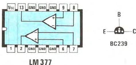
Fig. 2 Connessioni viste da sopra dell'integrato LM.377 e del transistor BC.239 visto invece da sotto. Come transistor si potranno utilizzare anche dei BC.109 metallici o altri equivalenti, purché la disposizione dei terminali E-B-C corrisponda con quelle del BC.239.
