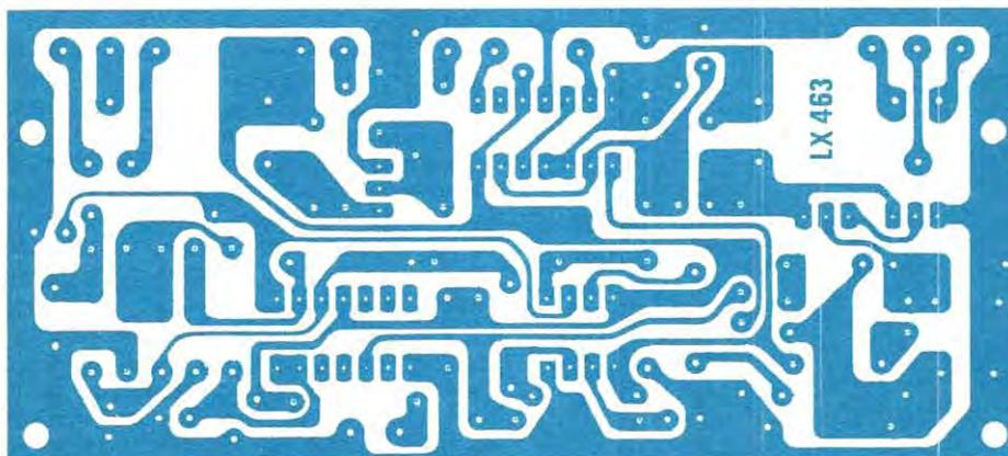
**Fig. 2** Disegno a grandezza naturale del circuito stampato LX463 necessario per questa realizzazione. Tale circuito viene fornito già forato e completo di disegno serigrafico dei componenti. Prima di iniziare il montaggio ricordarsi di effettuare il ponticello visibile nel disegno a lato, sopra l'integrato IC3.
