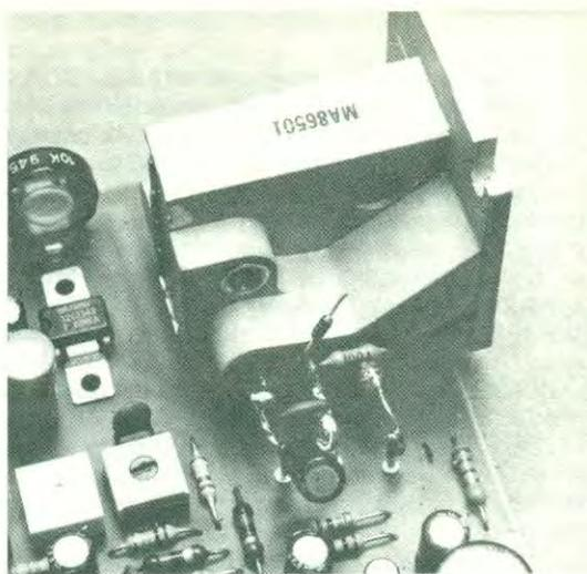
**Fig. 4** In questa foto si può vedere il diodo di protezione tranciato dal terminale RX e i condensatori C1 e C2 stagnati direttamente tra il terminale TX e quello di massa (terminale centrale). **NOTA** = la cavità potrà essere fissata sul circuito stampato con qualche goccia di collante cementatutto.
