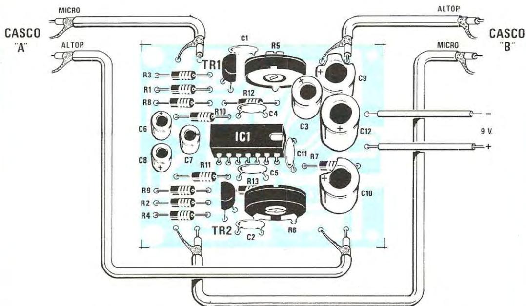
**Fig. 4** Schema pratico di montaggio. Si noti la tacca di riferimento dell'integrato e la parte sfaccettata dei due transistor rivolti uno in senso contrario all'altro. Attenzione a non sbagliarvi nel collegare la pila di alimentazione, cioè a non applicare il polo positivo dove andrebbe quello negativo o viceversa.
