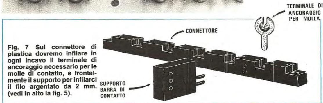
Fig. 7 Sul connettore di plastica dovremo infilare in ogni incavo il terminale di ancoraggio necessario per le molle di contatto, e frontalmente il supporto per infilarci il filo argentato da 2 mm. (vedi in alto la fig. 5).
