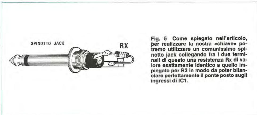
**Fig. 5** Come spiegato nell'articolo, per realizzare la nostra «chiave» potremo utilizzare un comunissimo spinotto jack collegando fra i due terminali di questo una resistenza Rx di valore esattamente identico a quello impiegato per R3 in modo da poter bilanciare perfettamente il ponte posto sugli ingressi di IC1.
