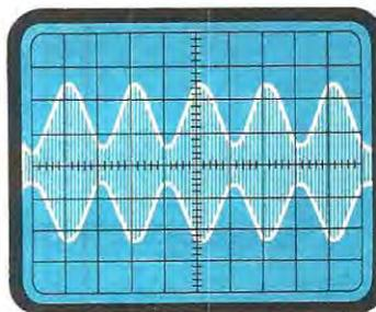
**Fig. 2** Modulando lo stesso segnale al 90% o 100% si otterrà un aumento in ampiezza e una diminuzione nella distanza che separa i picchi negativi delle semionde superiori dai picchi positivi delle semionde inferiori.
