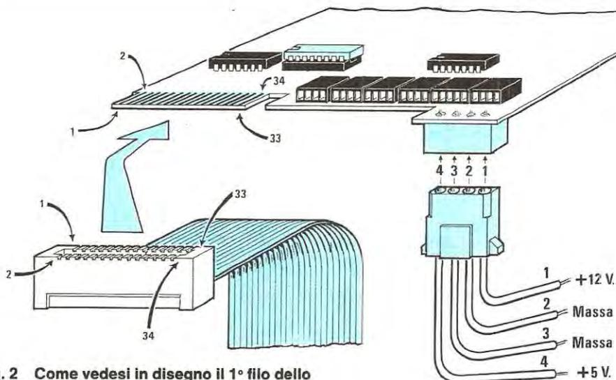
**Fig. 2** Come vedesi in disegno il 1° filo dello spinotto di alimentazione serve per i 12 volt positivi, i fili 2-3 sono di massa, mentre il filo 4 serve per i 5 volt positivi. Ricordarsi, quando si infila sulla sinistra il connettore della piattina a 34 fili, di controllare che i numeri 1-33 si trovino posti in basso e i numeri 2-34 in alto, diversamente provocheremo dei cortocircuiti in quanto tutte le piste inferiori (dall'1 al 33) sono di massa.
