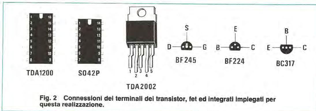
Fig. 2 Connessioni dei terminali dei transistor, fet ed integrati impiegati per questa realizzazione.
