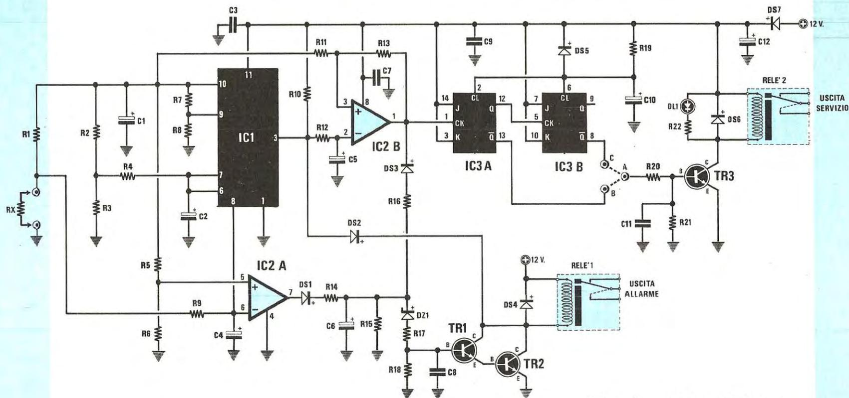
Fig. 1 Schema elettrico della nostra chiave elettronica per disinserire un antifurto. Come spiegato nell'articolo la resistenza Rx andrà stagnata nell'interno di una comunissima spina jack per cuffia. Per ottenere la maggior sicurezza possibile è consigliabile realizzare la Rx collegando in serie o in parallelo fra di loro due resistenze di valore standard.
