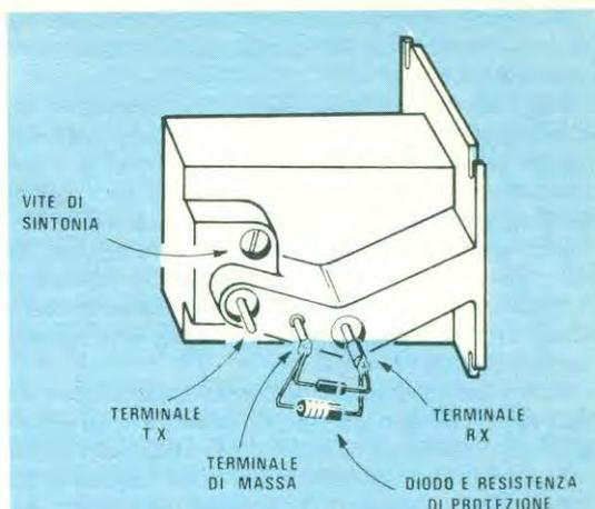
**Fig. 2** Guardando la cavità di lato, il terminale del diodo trasmittente è posto sulla sinistra (vedi terminale indicato TX) mentre quello del diodo ricevente sulla destra (vedi terminale RX). Il terminale centrale è quello di MASSA che dovrà essere collegato alla massa del circuito stampato. Il diodo e la resistenza collegati tra il terminale RX e la massa servono per proteggere il diodo Schottky da scariche elettrostatiche.
