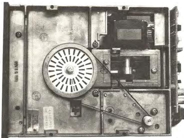
**Fig. 8** Collocando lo stroboscopo sotto una lampada alimentata dalla rete a 50 Hz e facendo ruotare il disco, quando questo è in movimento le linee interne debbono apparire immobili: se così non fosse occorrerà ruotare in un senso o nell'altro il trimmer che abbiamo posto in evidenza in fig. 1 fino a raggiungere lo scopo.
