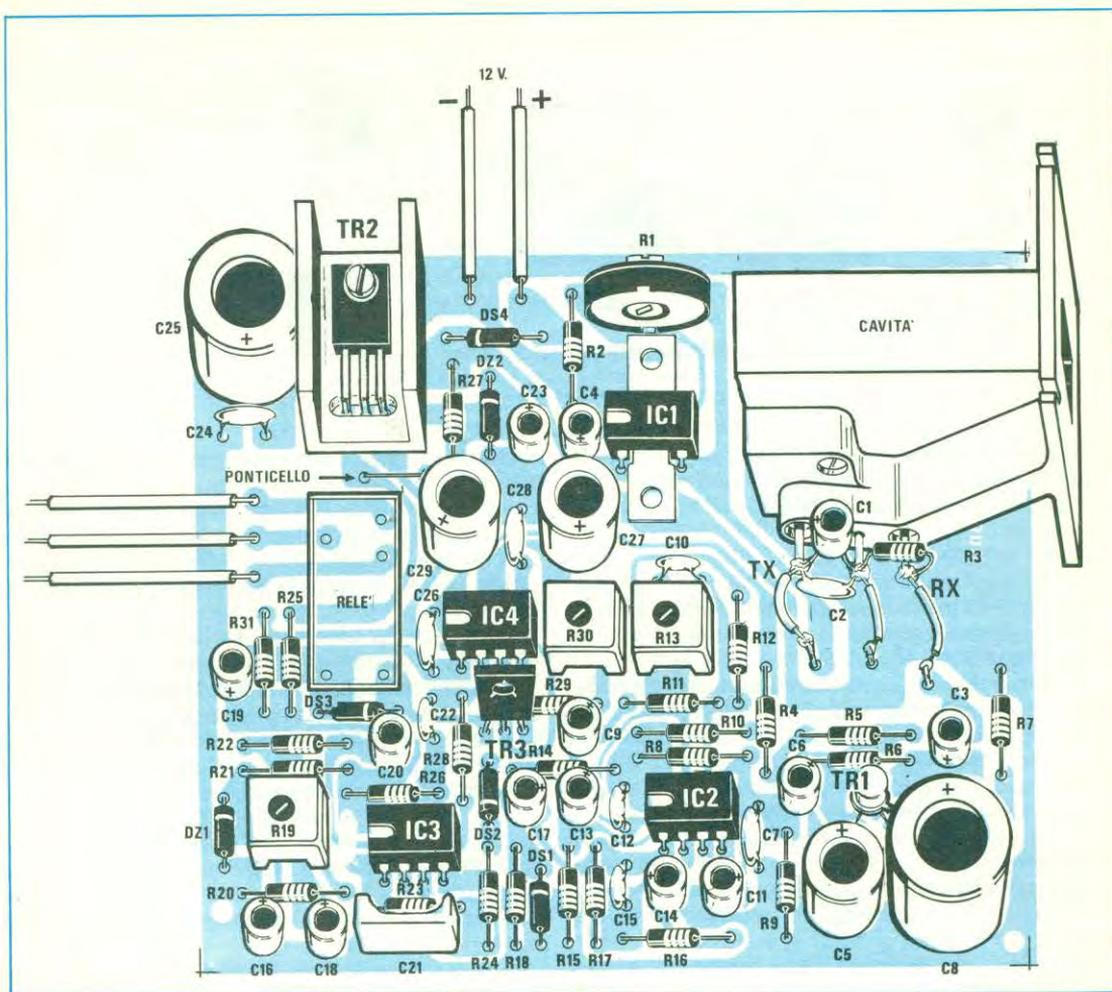
**Fig. 6** Schema pratico di montaggio dell'antifurto. Si notino i condensatori C1 e C2 stagnati direttamente sui terminali TX-MASSA della cavità e la resistenza R3 già presente tra il terminale RX-MASSA. Il transistor TR2 è necessario che venga dotato di un'aletta di raffreddamento a U.
