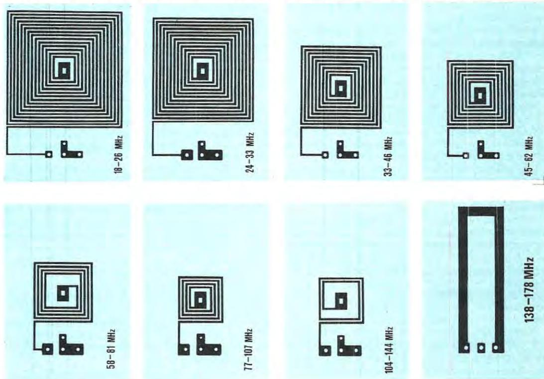
**Fig. 9** Per coprire tutta la gamma da 18 MHz a circa 180 MHz sono necessarie 8 bobine che vi forniremo già incise su circuito stampato. In questo disegno tali bobine sono riportate a grandezza naturale. **NOTA** = la gamma di frequenza incisa su ogni bobina è approssimata.
