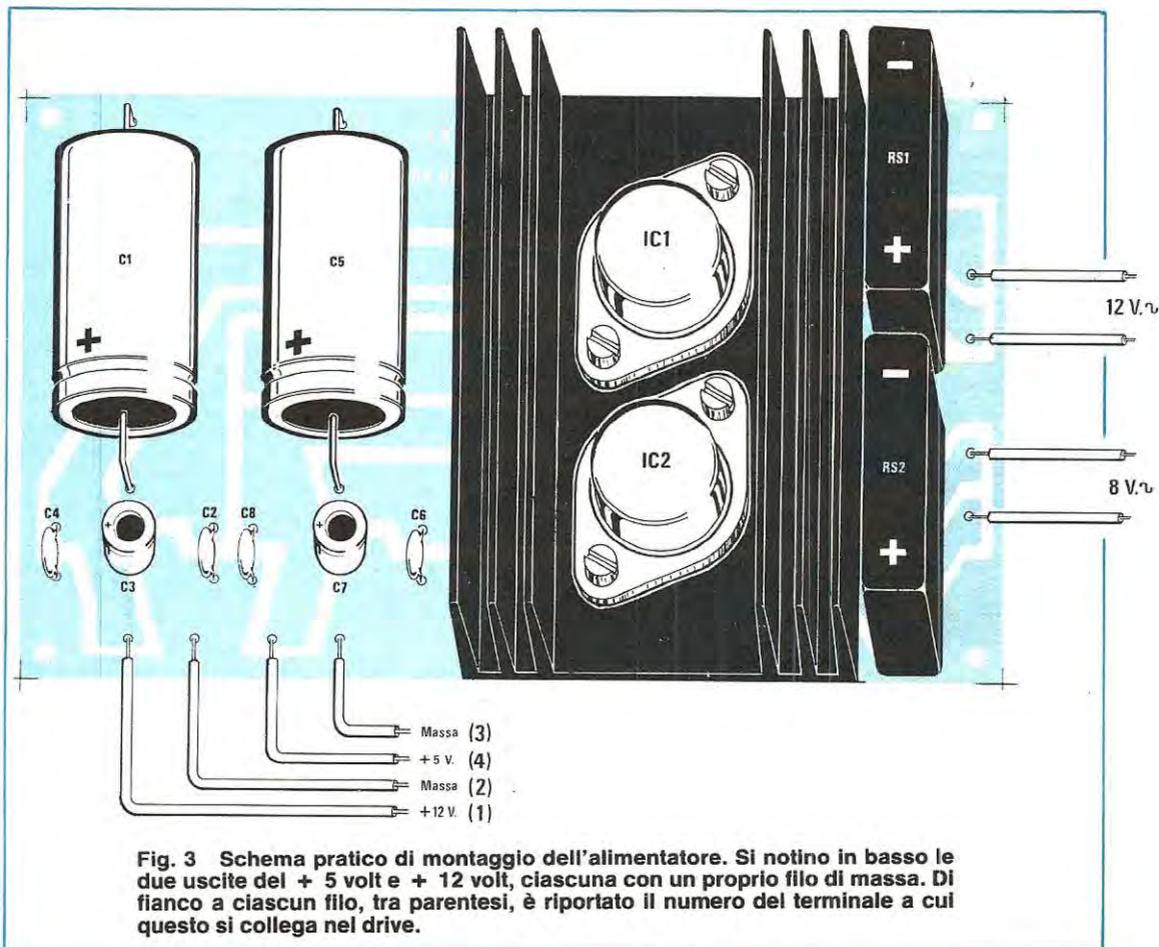
**Fig. 3** Schema pratico di montaggio dell'alimentatore. Si notino in basso le due uscite del + 5 volt e + 12 volt, ciascuna con un proprio filo di massa. Di fianco a ciascun filo, tra parentesi, è riportato il numero del terminale a cui questo si collega nel drive.
