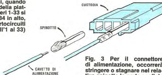
**Fig. 3** Per il connettore di alimentazione, occorrerà stringere o stagnare nel relativo spinotto la parte spellata del filo di rame, poi infilare il tutto dentro la custodia in plastica.
