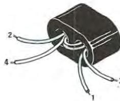
**Fig. 10** Disegno a grandezza naturale del circuito stampato LX466 e del trasformatore di accoppiamento T1 avvolto su nucleo in ferrite. Ricordatevi che i due avvolgimenti vanno effettuati con filo bifilare e collegati al circuito stampato in modo che risultino in opposizione di fase come riportato nello schema elettrico.
