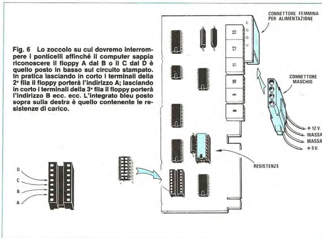
**Fig. 6** Lo zoccolo su cui dovremo interrompere i ponticelli affinché il computer sappia riconoscere il floppy A dal B o il C dal D è quello posto in basso sul circuito stampato. In pratica lasciando in corto i terminali della 2<sup>a</sup> fila il floppy porterà l'indirizzo A; lasciando in corto i terminali della 3<sup>a</sup> fila il floppy porterà l'indirizzo B ecc. ecc. L'integrato bleu posto sopra sulla destra è quello contenente le resistenze di carico.
