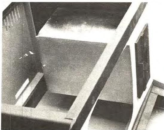
**Fig. 9** Se nell'interno del mobile il floppy non risulta schermato con una lamiera a U, il giogo di deflessione del monitor video lo può influenzare impedendone così il regolare funzionamento. Nella foto di sinistra si può vedere tale schermo applicato dentro il mobile.
