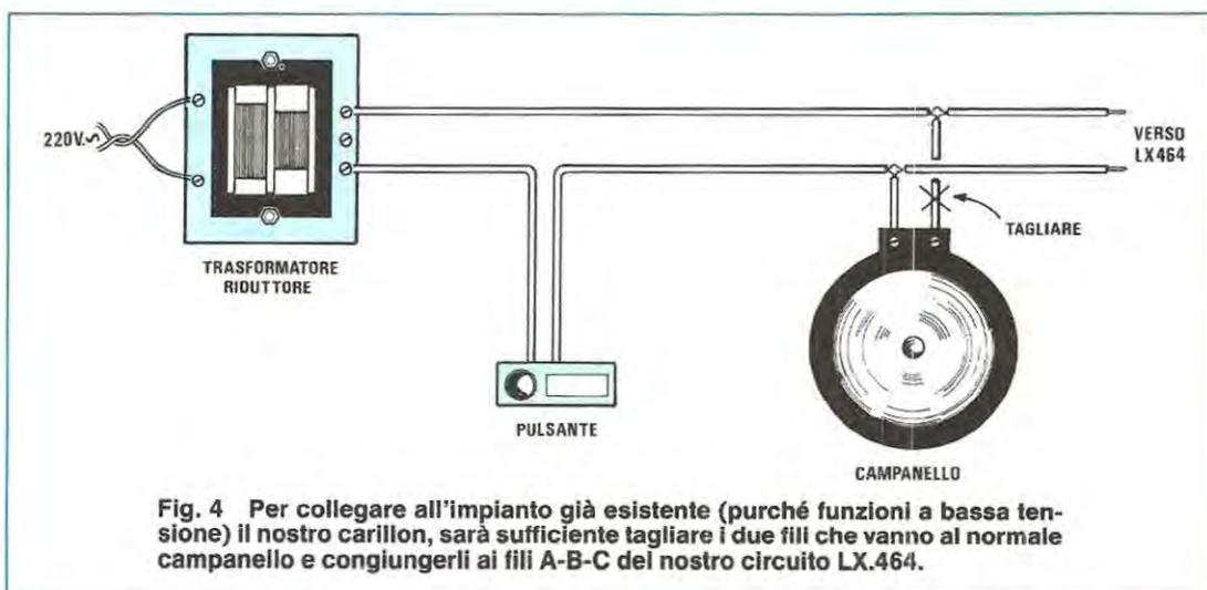
**Fig. 4** Per collegare all'impianto già esistente (purché funzioni a bassa tensione) il nostro carillon, sarà sufficiente tagliare i due fili che vanno al normale campanello e congiungerli ai fili A-B-C del nostro circuito LX.464.
