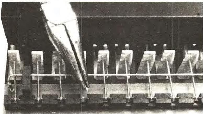
Per innestare le mollette di contatto sarà sufficiente infilarle nell'asola del tasto e tirarle di quel tanto necessario per poterle inserire nel terminale di ancoraggio (vedi fig. 7). Se userete una pinza non stringete troppo la molla per non schiacciarla.
