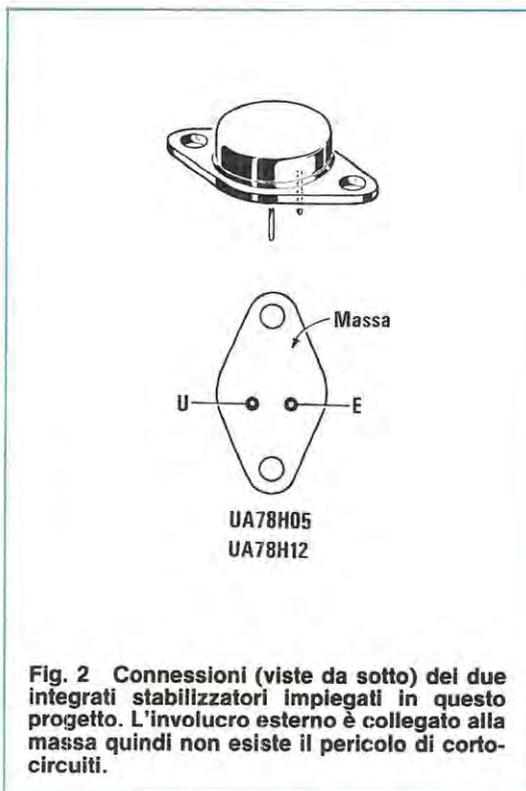
**Fig. 2** Connessioni (viste da sotto) dei due integrati stabilizzatori impiegati in questo progetto. L'involucro esterno è collegato alla massa quindi non esiste il pericolo di cortocircuiti.
