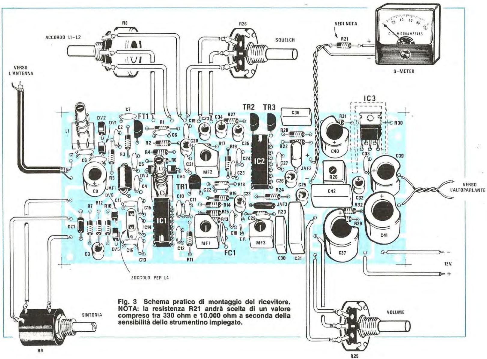
**Fig. 3** Schema pratico di montaggio del ricevitore.
