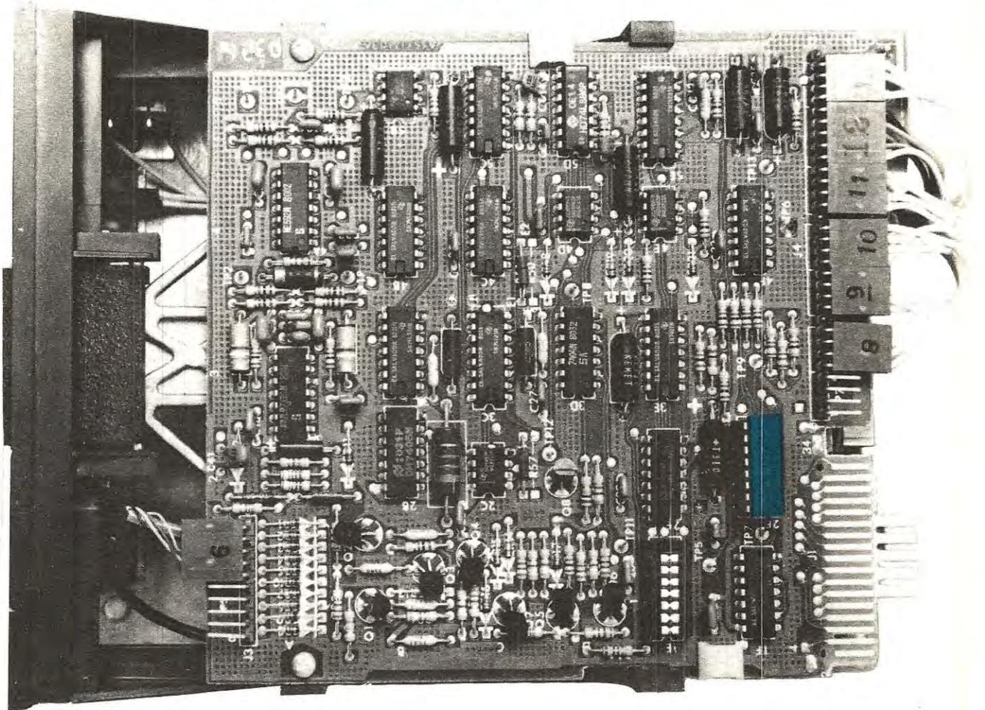
**Ogni drive per floppy-disk, oltre al motorino per la rotazione, a quello passo-passo per gli spostamenti della testina e alla testina stessa, dispone di una scheda elettronica sulla quale sono presenti diversi integrati, resistenze e transistor.**
