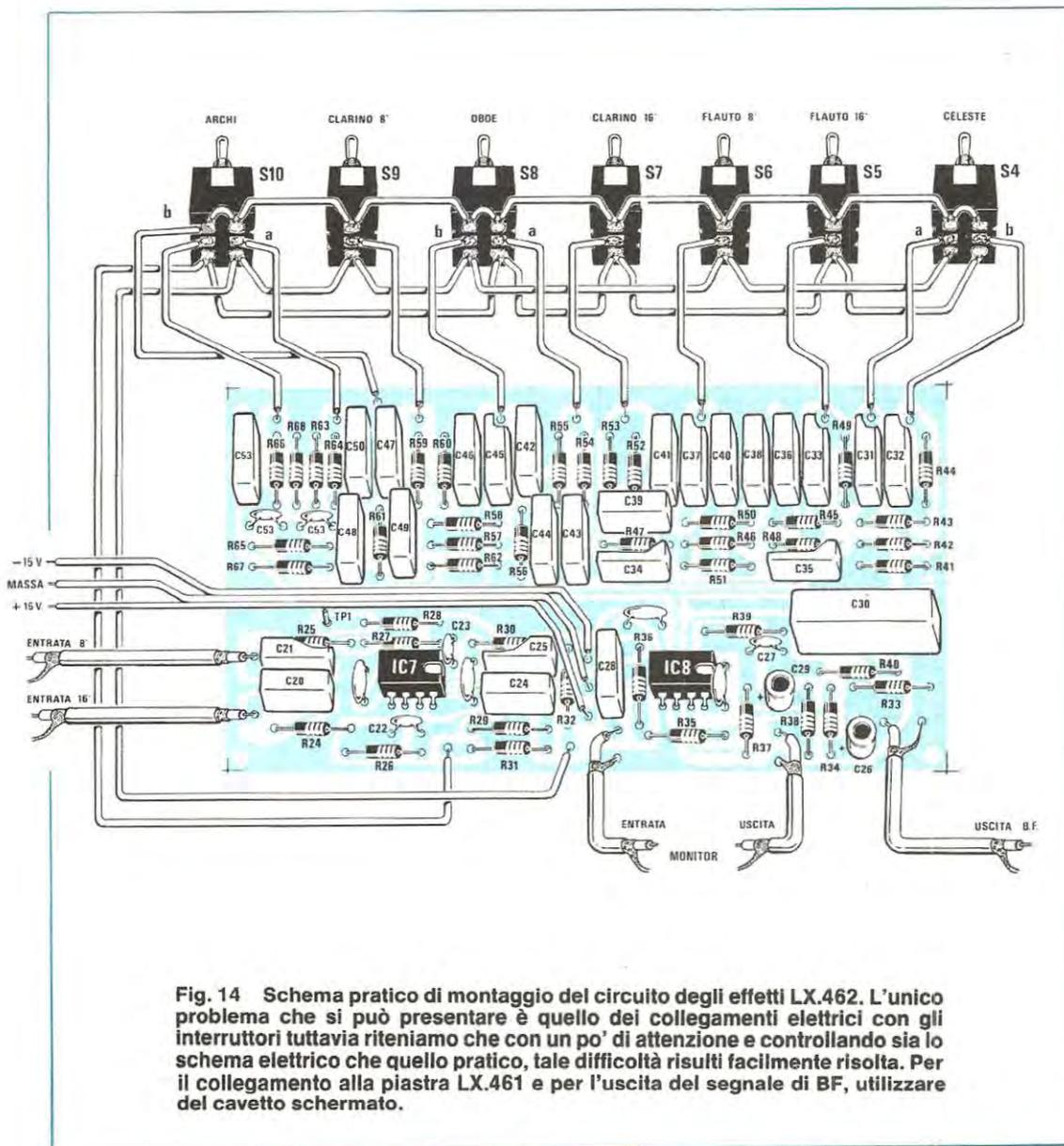
**Fig. 14** Schema pratico di montaggio del circuito degli effetti LX.462. L'unico problema che si può presentare è quello dei collegamenti elettrici con gli interruttori tuttavia riteniamo che con un po' di attenzione e controllando sia lo schema elettrico che quello pratico, tale difficoltà risulti facilmente risolta. Per il collegamento alla piastra LX.461 e per l'uscita del segnale di BF, utilizzare del cavetto schermato.
