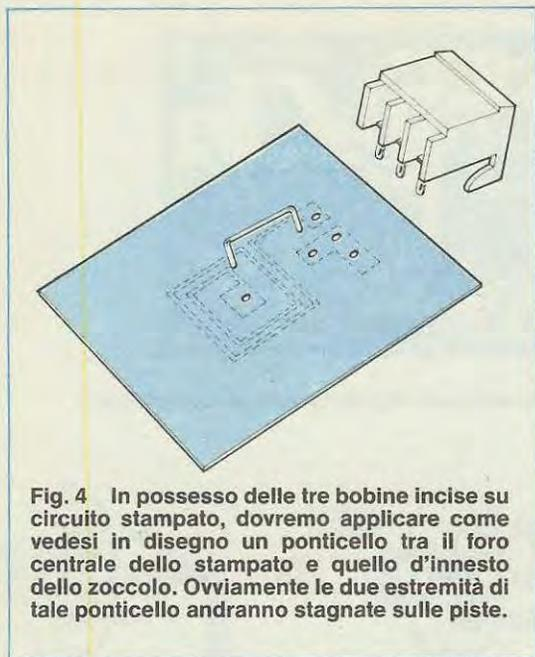
**Fig. 4** In possesso delle tre bobine incise su circuito stampato, dovremo applicare come vedesi in disegno un ponticello tra il foro centrale dello stampato e quello d'innesto dello zoccolo. Ovviamente le due estremità di tale ponticello andranno stagnate sulle piste.
