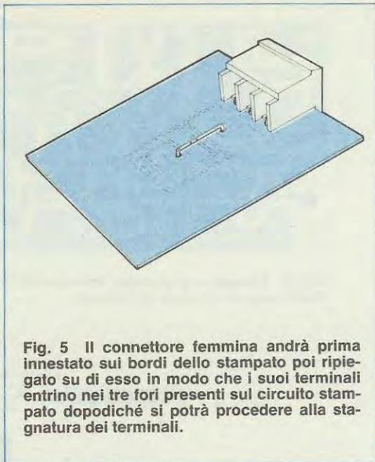
**Fig. 5** Il connettore femmina andrà prima innestato sui bordi dello stampato poi ripiegato su di esso in modo che i suoi terminali entrino nei tre fori presenti sul circuito stampato dopodiché si potrà procedere alla stagnatura dei terminali.
