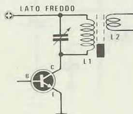
**Fig. 6** Se anche si avvolge la bobina L2 sul lato freddo di L1 e si inserisce il nucleo ferromagnetico dal lato opposto si otterrà lo stesso risultato descritto per la fig. 5, cioè un minor trasferimento di energia di AF dalla bobina L1 a L2 pur assorbendo il transistor una elevata corrente.
