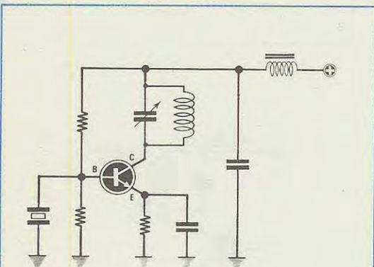
**Fig. 7** Normalmente in uno schema elettrico non ci si sofferma a riportare su un'unica «massa» i componenti relativi a quel determinato stadio, ma quasi sempre, si utilizza un segno di massa collocato nella posizione più comoda o più estetica.
