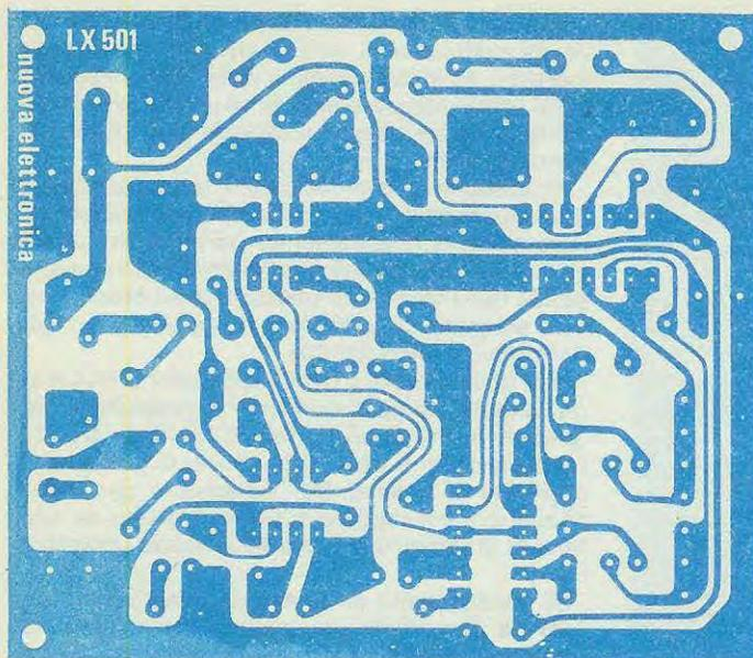
**Fig. 7** Disegno a grandezza naturale del circuito stampato necessario per questa realizzazione. Tutti i nostri circuiti sono in fibra di vetro e vengono forniti già forati e completi di disegno serigrafico.
