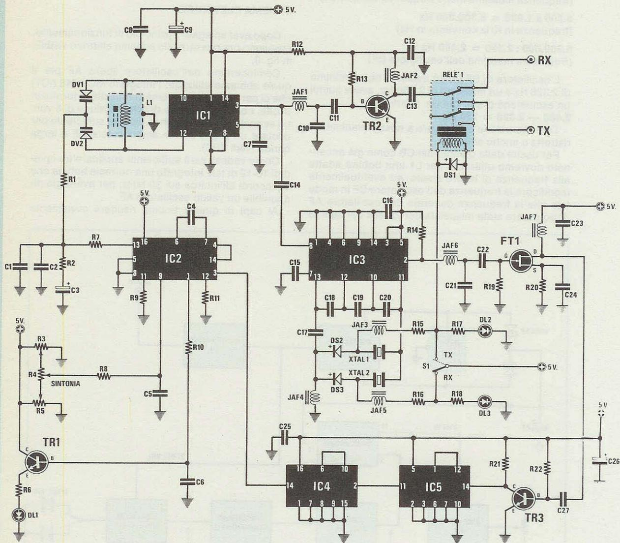
**Fig. 9** Schema elettrico del VFO a PLL. Commutando il deviatore S1 per passare dalla ricezione alla trasmissione, sullo stadio oscillatore/miscelatore (IC3) inseriremo il quarzo XTAL1 da 21.400 KHz e contemporaneamente ecciteremo il relè che commuterà il segnale AF dall'uscita RX su quella TX. Tutti i terminali indicati + 5 volt andranno a collegarsi allo stadio alimentatore riportato in fig. 10.
