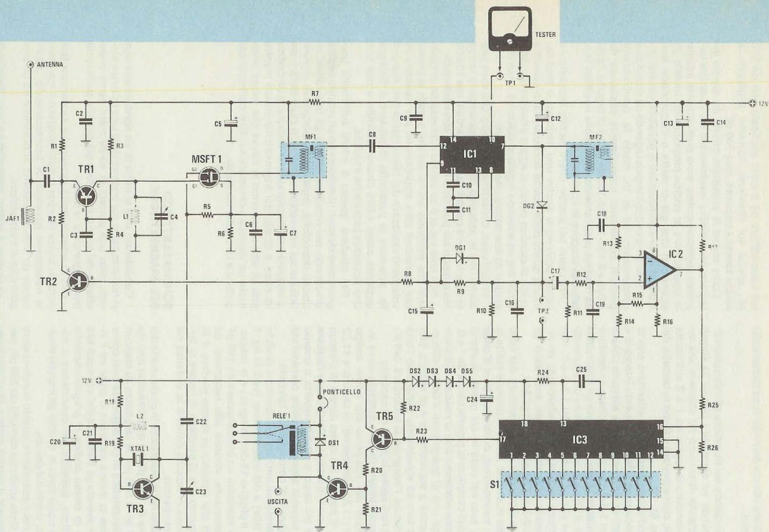
Fig. 8 Schema elettrico del ricevitore. Lo strumento posto in alto sui terminali TP1 serve esclusivamente per la sola fase di taratura come spiegato nell'articolo. Il ponticello che alimenta il relé 1 dovremo inserirlo solo nel caso che non utilizzassimo l'automatismo descritto in questo stesso numero.
