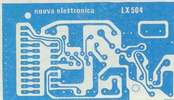
Fig. 10 Disegno a grandezza naturale del circuito stampato necessario per il trasmettitore
