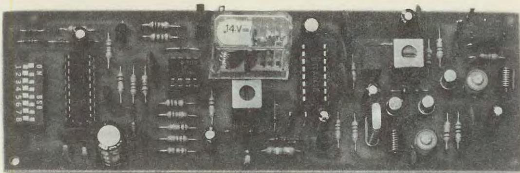
Foto del ricevitore per radiocomando. Si noti sulla sinistra l'interruttore dip switch necessario per impostare il codice chiave identico a quello del trasmettitore.
