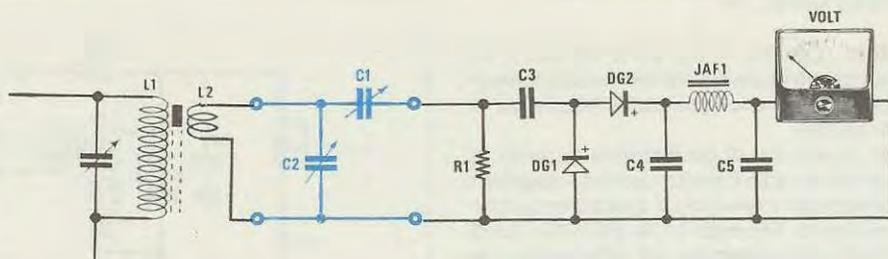
Fig. 21 Normalmente l'impedenza della bobina link L2 di un oscillatore AF risulta quasi sempre minore di 56 ohm, pertanto per adattarla alla nostra sonda di carico dovremo collegare i due condensatori C1-C2 come riportato in questo disegno. Se farete delle prove potrete constatare che adattando l'impedenza si riesce a volte ad ottenere un aumento di potenza del 100%.
