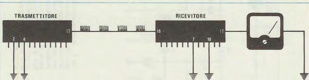
Fig. 5 Se nel trasmettitore abbiamo collegato a massa i piedini 2 e 4 mentre nel ricevitore altri diversi piedini questo non riconoscerà gli impulsi del trasmettitore e sul piedino 17 sarà sempre presente una tensione positiva.
