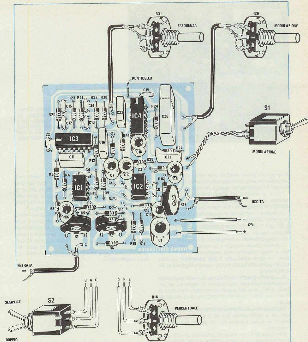
**Fig. 8** Schema pratico di montaggio del Chopper-Vox. Ricordatevi di effettuare il ponticello visibile in alto sopra a IC4 e di utilizzare del cavetto schermato per i collegamenti ai potenziometri di frequenza e modulazione. I fili che fanno capo ai terminali di S2 e R14 (vedi in basso) siglati con lettere B-A-C e D-F-E andranno a collegarsi ai relativi terminali posti sul circuito stampato tra IC1 e IC2.
