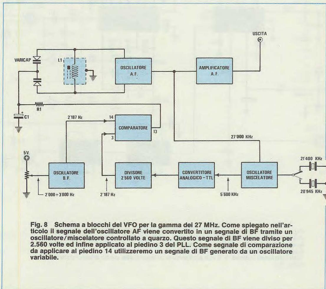
**Fig. 8** Schema a blocchi del VFO per la gamma dei 27 MHz. Come spiegato nell'articolo il segnale dell'oscillatore AF viene convertito in un segnale di BF tramite un oscillatore/miscelatore controllato a quarzo. Questo segnale di BF viene diviso per 2.560 volte ed infine applicato al piedino 3 del PLL. Come segnale di comparazione da applicare al piedino 14 utilizzeremo un segnale di BF generato da un oscillatore variabile.
