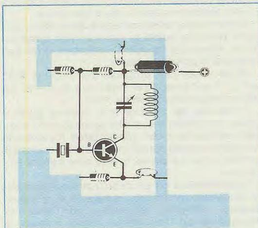
Fig. 9 Se realizzando un circuito stampato collocate i terminali dei vari componenti da applicare a «massa» in punti diversi e notevolmente distanti tra di loro è facile che il circuito autooscilli, e che le piste di rame si comportino come tante piccole induttanze.
