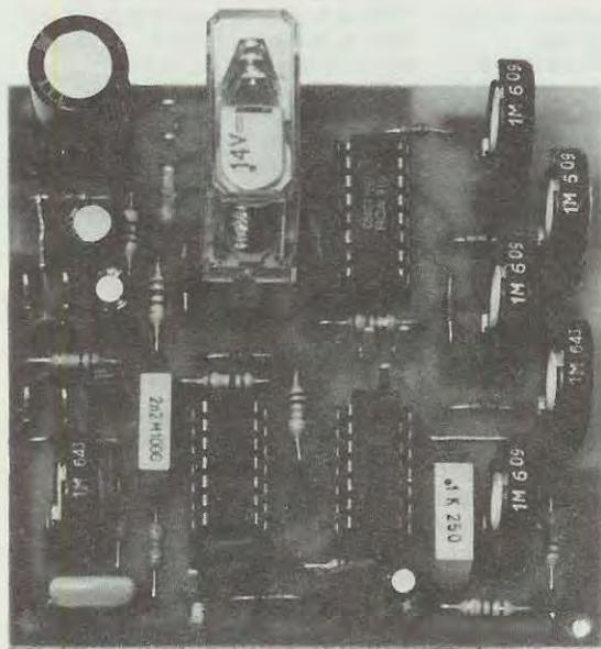
Foto del circuito descritto in questo articolo. Notare il relè per il passaggio da trasmissione a ricezione e i quattro trimmer necessari per modificare le frequenze delle quattro note generate.
