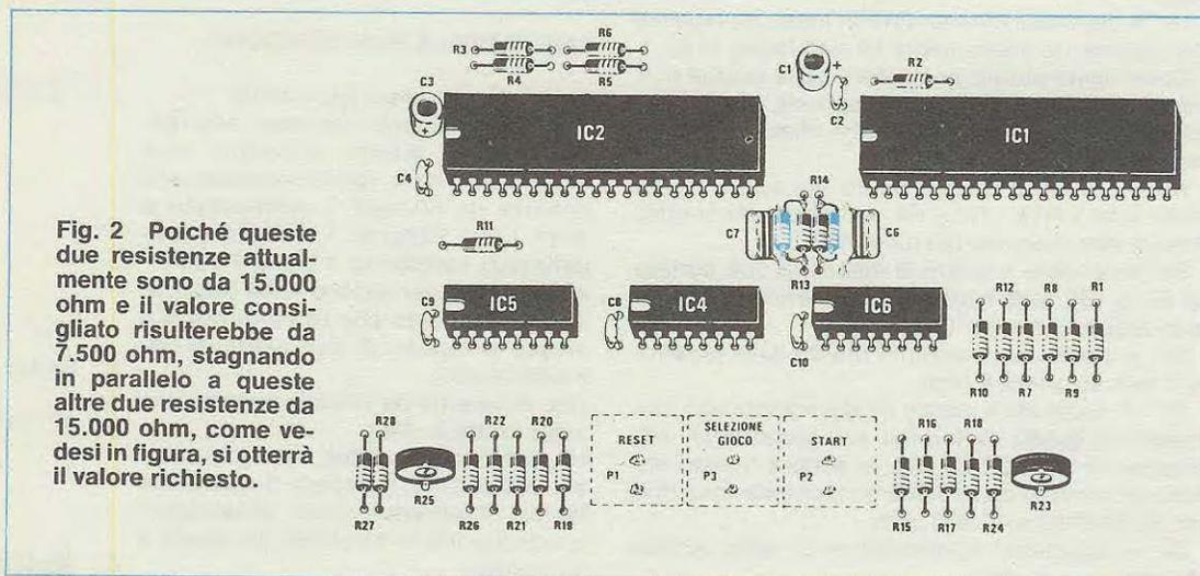
Fig. 2 Poiché queste due resistenze attualmente sono da 15.000 ohm e il valore consigliato risulterebbe da 7.500 ohm, stagnando in parallelo a queste altre due resistenze da 15.000 ohm, come vedesi in figura, si otterrà il valore richiesto.
