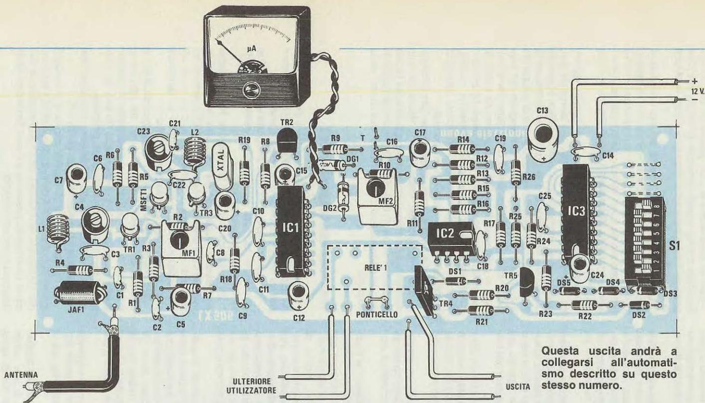
Fig. 12 Disegno a grandezza naturale del circuito stampato del ricevitore e schema pratico di montaggio. Lo strumento lo utilizzeremo solo in fase di taratura. Il ponticello posto in prossimità del relè andrà effettuato solo se non sarà collegato al nostro automatismo.
