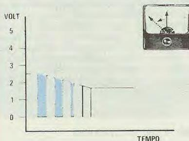
**Fig. 3** Quando il PLL ha agganciato la frequenza dell'oscillatore AF, se questa tendesse leggermente ad aumentare, l'interruttore S2 presente nell'interno del PLL fornirebbe in uscita degli impulsi negativi più o meno ampi per poter ridurre la tensione del condensatore elettrolitico C1 e quindi sui diodi varicap.
