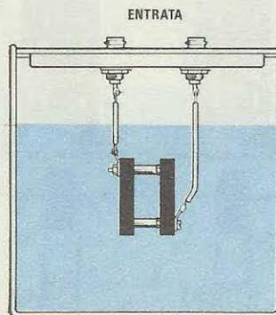
**Fig. 6** Volendo tenere collegato per molto tempo il nostro wattmetro ad un amplificatore di elevata potenza, si consiglia di collocare dentro un barattolo pieno d'olio le due resistenze da 50 watt. In questo caso il deviatore S2 dovremo commutarlo in posizione «carico esterno».
