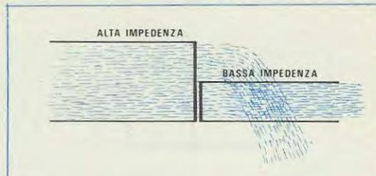
Fig. 16 Lo stesso dicasi se al rubinetto fosse applicato un tubo di diametro elevato e all'estremità di questo venisse appoggiato un tubo di diametro inferiore. Non essendo i due tubi dello stesso diametro sprecheremmo molta acqua.
