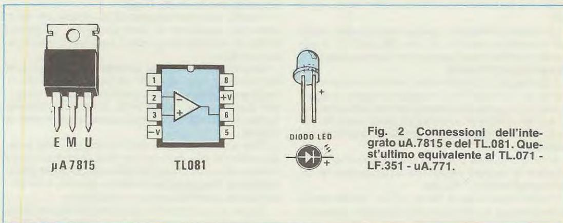
Fig. 2 Connessioni dell'integrato uA.7815 e del TL.081. Quest'ultimo equivalente al TL.071 - LF.351 - uA.771.
