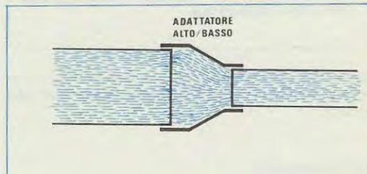
Fig. 18 Se alla sorgente è collegato un tubo di diametro elevato e a tale estremità volessimo collegare un tubo di diametro inferiore, potremo prendere lo stesso identico «adattatore» utilizzato in fig. 17 e collegarlo in senso contrario.
