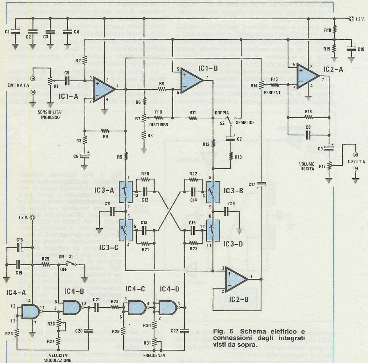
Fig. 6 Schema elettrico e connessioni degli integrati visti da sopra.
