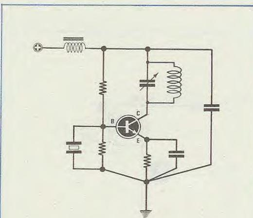
**Fig. 8** In pratica tutti i condensatori di disaccoppiamento e le resistenze dovrebbero come in questo disegno far capo ad un'unica massa collocata il più vicino possibile al condensatore e la resistenza di polarizzazione di emettitore.
