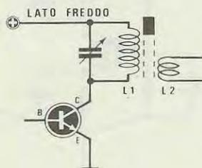
**Fig. 5** Avvolgendo L2 sul lato caldo di L1 il transistor oscillatore risulterà troppo «caricato» di conseguenza questo assorbirà maggior corrente del richiesto surriscaldandosi tanto fino a bruciarsi. Se poi il nucleo risulta inserito dal lato opposto non si riuscirà ad ottenere un ottimo trasferimento di AF da L1 a L2.
