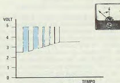
**Fig. 4** Se invece la frequenza dell'oscillatore AF tendesse a diminuire sarà l'interruttore S1 ad entrare in azione, fornendo in uscita sul piedino 13 degli impulsi positivi per poter aumentare la tensione sul condensatore elettrolitico C1 e di conseguenza ai diodi varicap.
