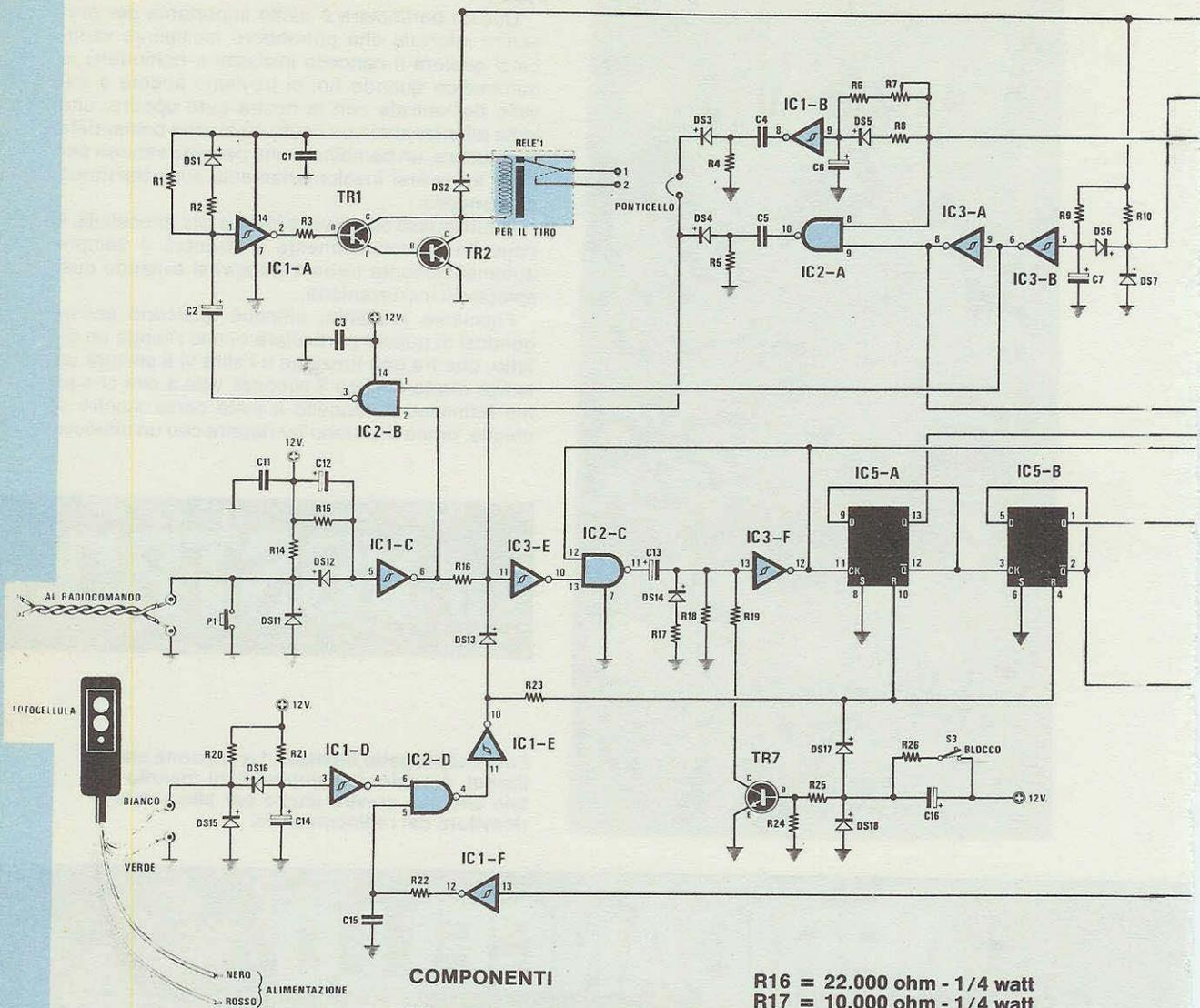
Fig. 1 Schema elettrico dell'automatismo completo di alimentatore stabilizzato. La tensione di 24 volt erogata da RS2 servirà per alimentare la fotocellula.
