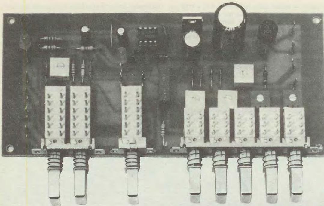
Continueremo montando i condensatori poliestere, i trimmer, il ponte raddrizzatore RS1, l'integrato stabilizzatore uA 7815, ponendolo con il lato metallico rivolto come vedesi nel disegno pratico, i condensatori elettrolitici (attenti alle polarità), e per ultimi i commutatori a slitta.
