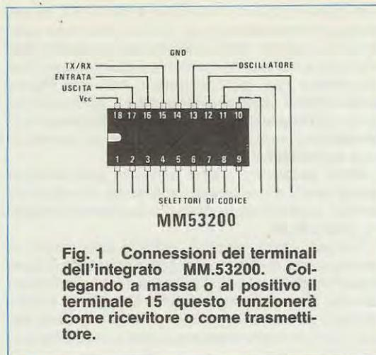
**Fig. 1** Connessioni dei terminali dell'integrato MM.53200. Collegando a massa o al positivo il terminale 15 questo funzionerà come ricevitore o come trasmettitore.
