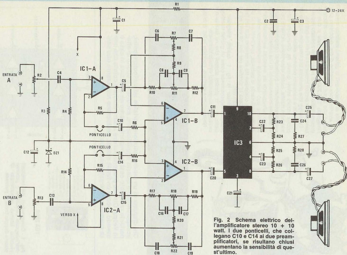
Fig. 2 Schema elettrico dell'amplificatore stereo 10 + 10 watt. I due ponticelli, che collegano C10 e C14 ai due preamplificatori, se risultano chiusi aumentano la sensibilità di quest'ultimo.
