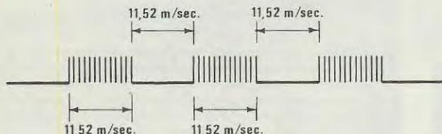
**Fig. 3** In pratica tale integrato fornirà in continuazione tanti treni d'onda, separati da pause di identica durata.
