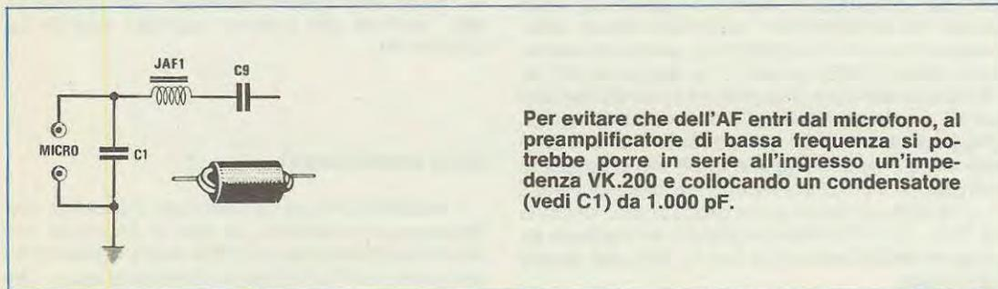
Per evitare che dell'AF entri dal microfono, al preamplificatore di bassa frequenza si potrebbe porre in serie all'ingresso un'impedenza VK.200 e collocando un condensatore (vedi C1) da 1.000 pF.
