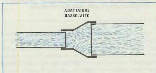
Fig. 17 Se non è possibile disporre di due tubi con identico diametro per ottenere il totale trasferimento da un tubo piccolo ad uno grande dovremmo cercare di interporre tra i due tubi così diversi un «adattatore» come vedesi in figura.
