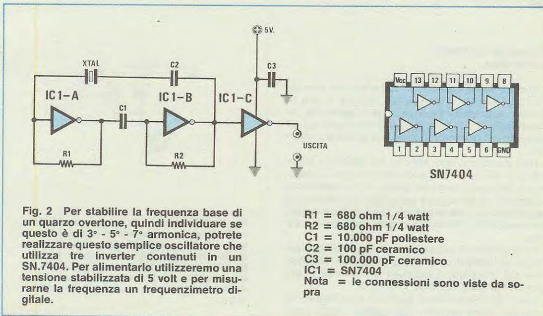
Fig. 2 Per stabilire la frequenza base di un quarzo overtone, quindi individuare se questo è di 3° - 5° - 7° armonica, potrete realizzare questo semplice oscillatore che utilizza tre inverter contenuti in un SN.7404. Per alimentarlo utilizzeremo una tensione stabilizzata di 5 volt e per misurarne la frequenza un frequenzimetro digitale.
