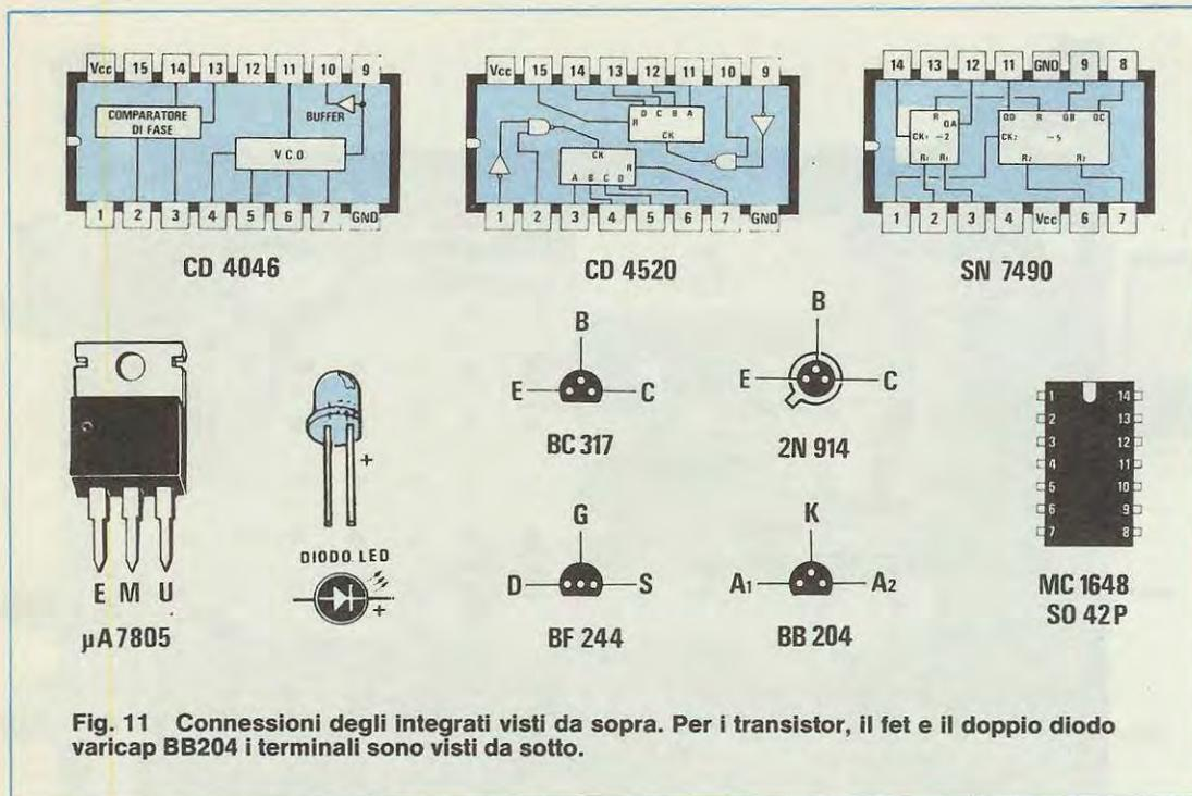
Fig. 11 Connessioni degli integrati visti da sopra. Per i transistor, il fet e il doppio diodo varicap BB204 i terminali sono visti da sotto.
