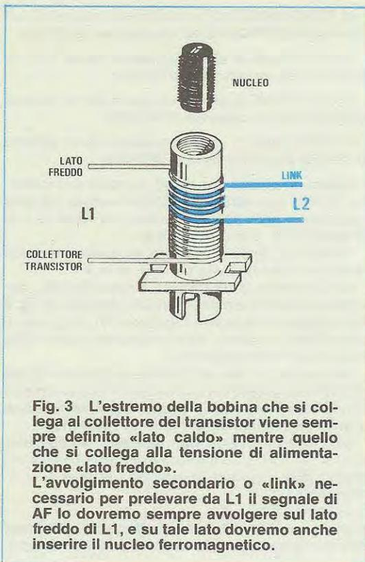
**Fig. 3** L'estremo della bobina che si collega al collettore del transistor viene sempre definito «lato caldo» mentre quello che si collega alla tensione di alimentazione «lato freddo».
