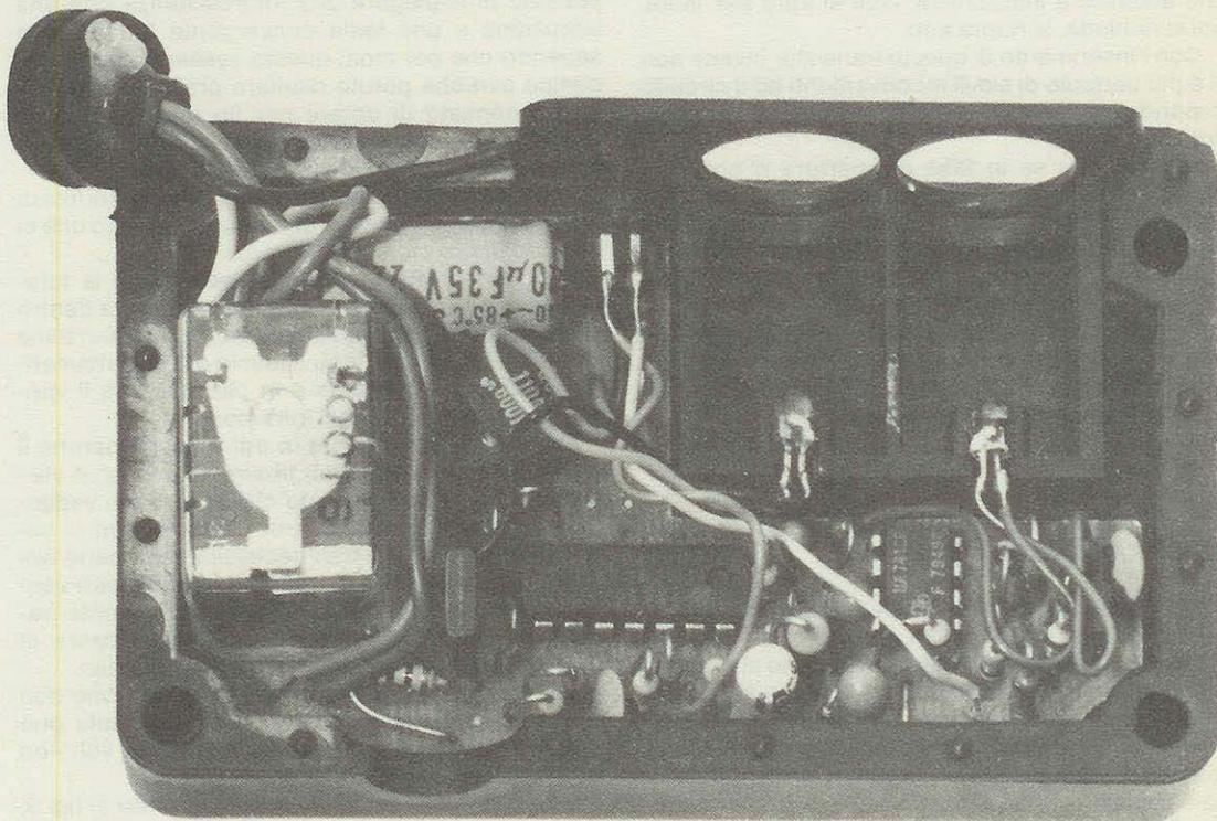
Nell'interno di questa fotocellula è presente un completo circuito elettronico comprendente uno stadio trasmittente a raggi infrarossi, uno ricevente e uno stadio pilota per il relè. I due diodi trasmettenti e riceventi sono già fissati all'esatta distanza focale dalle due lenti convergenti.
