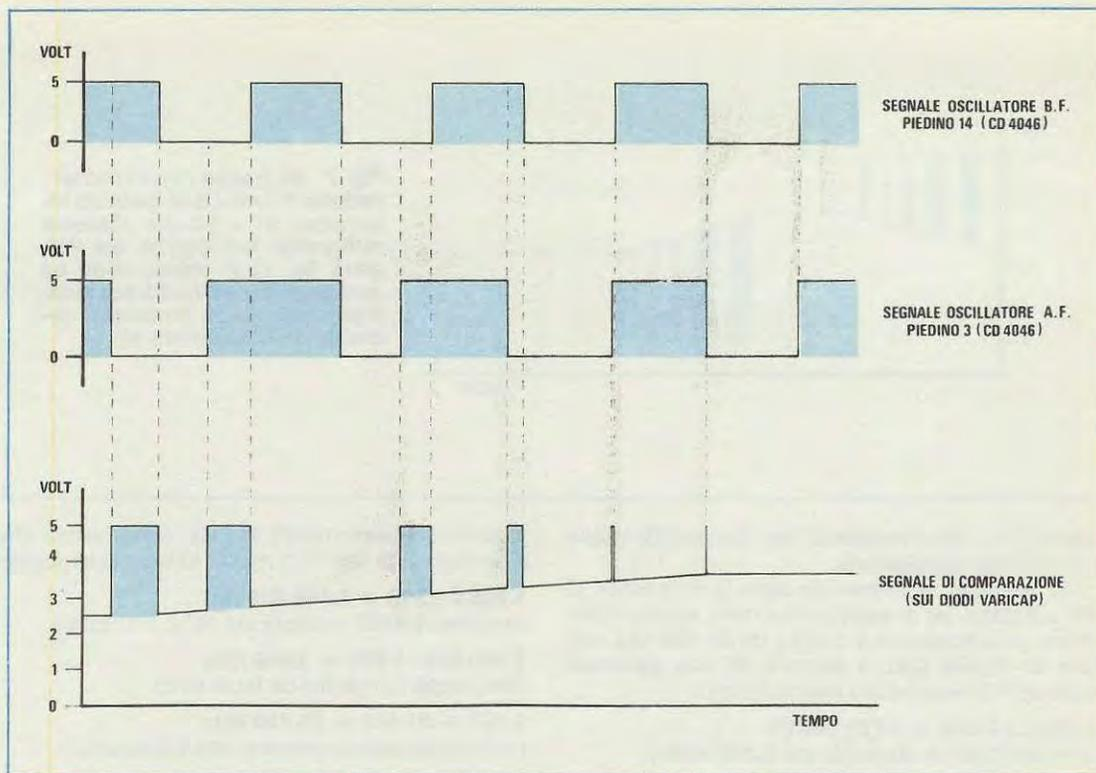
**Fig. 6** Ammettendo che la frequenza dell'oscillatore AF tendesse a diminuire, il PLL confrontando la fase dei due segnali si accorgerebbe di questo errore e di conseguenza dovendo aumentare la tensione sui diodi varicap, sarà l'interruttore S1 presente nell'interno del PLL a chiudersi ad intervalli decrescenti per aumentare la tensione positiva al condensatore C1 e ai diodi varicap.
