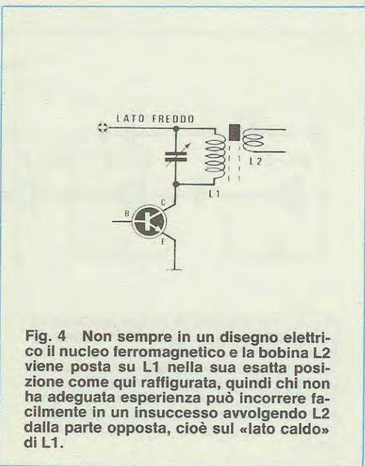
**Fig. 4** Non sempre in un disegno elettrico il nucleo ferromagnetico e la bobina L2 viene posta su L1 nella sua esatta posizione come qui raffigurata, quindi chi non ha adeguata esperienza può incorrere facilmente in un insuccesso avvolgendo L2 dalla parte opposta, cioè sul «lato caldo» di L1.
