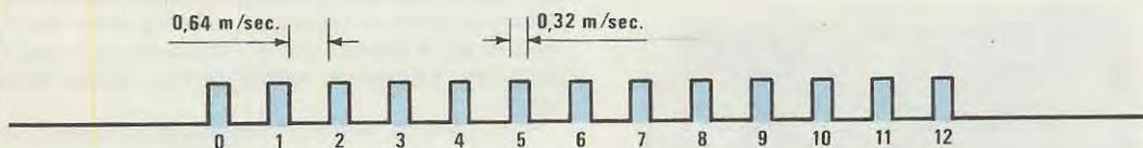
**Fig. 2** Se tutti i terminali per la selezione del codice di chiave risultano aperti dall'integrato usciranno in continuazione 13 impulsi della durata di 0,32 millisecondi distanziati tra di loro esattamente di 0,64 millisecondi. Questo treno d'onde avrà una durata totale di 11,52 millisecondi e dopo una pausa di uguale tempo ne seguirà il secondo poi il terzo ecc. ecc.
