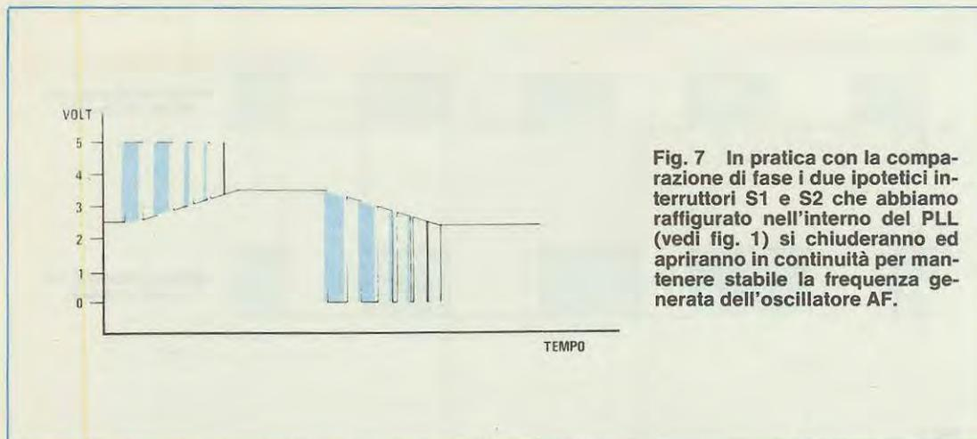
**Fig. 7** In pratica con la comparazione di fase i due ipotetici interruttori S1 e S2 che abbiamo raffigurato nell'interno del PLL (vedi fig. 1) si chiuderanno ed apriranno in continuità per mantenere stabile la frequenza generata dell'oscillatore AF.
