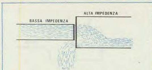
Fig. 15 Se ad un rubinetto noi collegassimo un tubo di piccolo diametro e all'estremità di questo per prelevare l'acqua erogata appoggassimo un tubo di diametro notevolmente maggiore, molta acqua la perderemmo da questa imperfetta giunzione.
