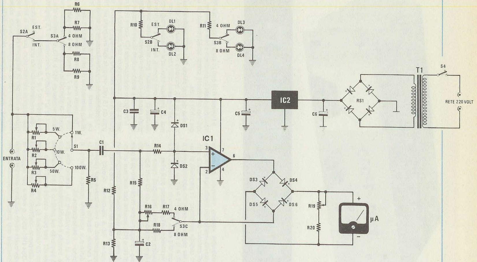
Fig. 1 Schema elettrico del wattmetro di BF descritto nell'articolo.
