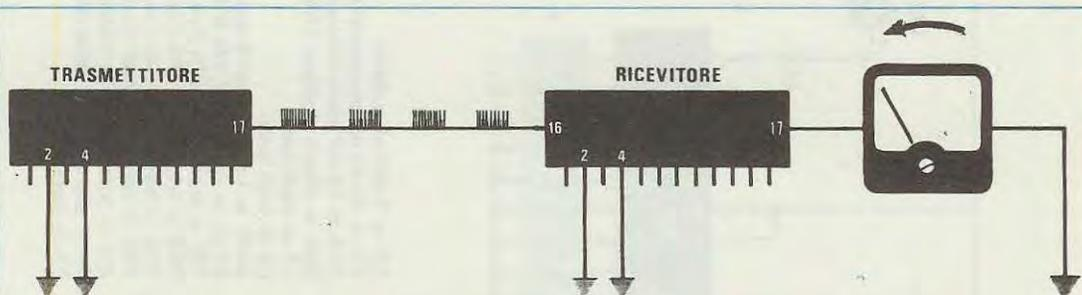
Fig. 6 Se anche l'integrato del ricevitore ha collegato a massa gli stessi identici piedini che risultano collegati nel trasmettitore, dopo quattro treni d'onda, il ricevitore darà la sua conferma di segnale valido, ponendo a massa il piedino di uscita 17.
