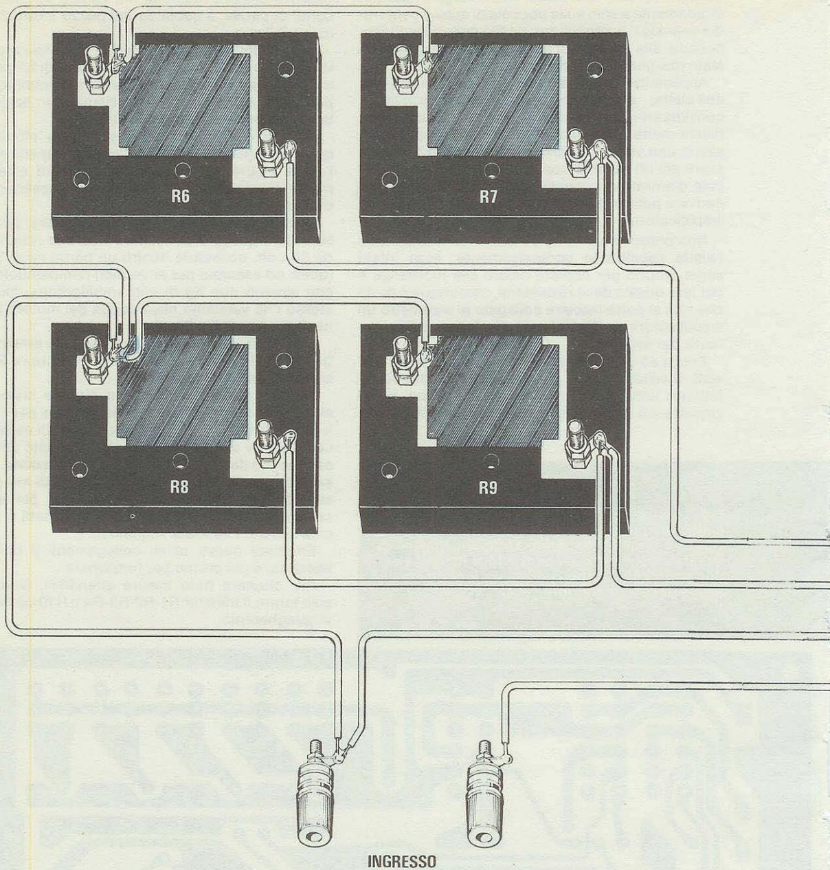
**Fig. 4** Le resistenze di potenza, dopo essere state collegate in parallelo, dovremo fissarle alle alette di raffreddamento presenti sui lati del mobile.
