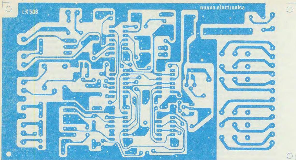
**Fig. 3** Disegno a grandezza naturale del circuito stampato necessario per la realizzazione di questo automatismo. Il circuito è a doppia faccia, quindi dovremo collegare tramite i fori passanti tutte le piste superiori con quelle inferiori.
