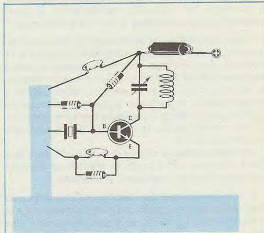
Fig. 10 Per ogni stadio predisponete una propria pista di massa e su questa non collocate altri condensatori o resistenze di stadi diversi. Solo così facendo si potranno eliminare autooscillazioni o funzionamenti anomali degli stadi che seguono.
