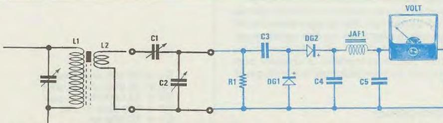
Fig. 22 La base di un transistor preamplificatore AF presenta normalmente una impedenza minore di quella della bobina L2, pertanto a differenza del caso precedente, l'adattatore di impedenza lo dovremo capovolgere cioè collegare a L2 il condensatore C1 e prelevare il segnale AF dalla giunzione C1-C2. Se sostituite sulla sonda di carico la resistenza R1 da 56 ohm con una da 10 ohm a carbone, constaterete che solo così facendo si otterrà un perfetto adattamento tra L2 e R1.
