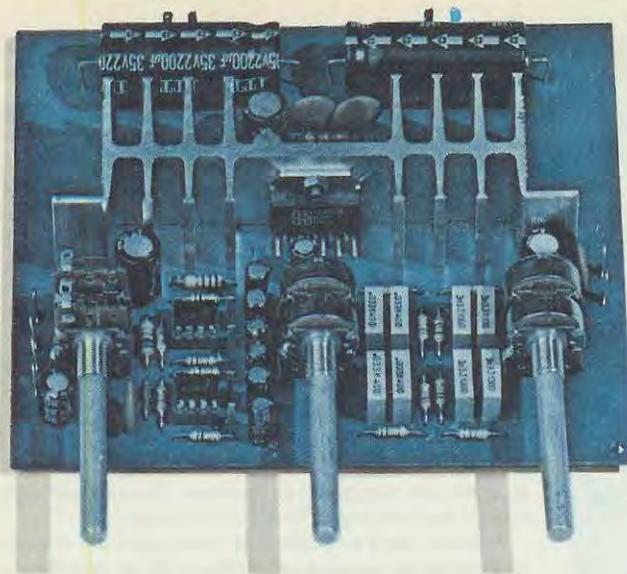
Foto dell'amplificatore montato. L'integrato TDA.2009 verrà fissato all'aletta di raffreddamento che troverete inclusa nel Kit. Volendo alimentare l'amplificatore con una tensione di 24 volt consigliamo di aumentare le dimensioni dell'aletta di raffreddamento.
