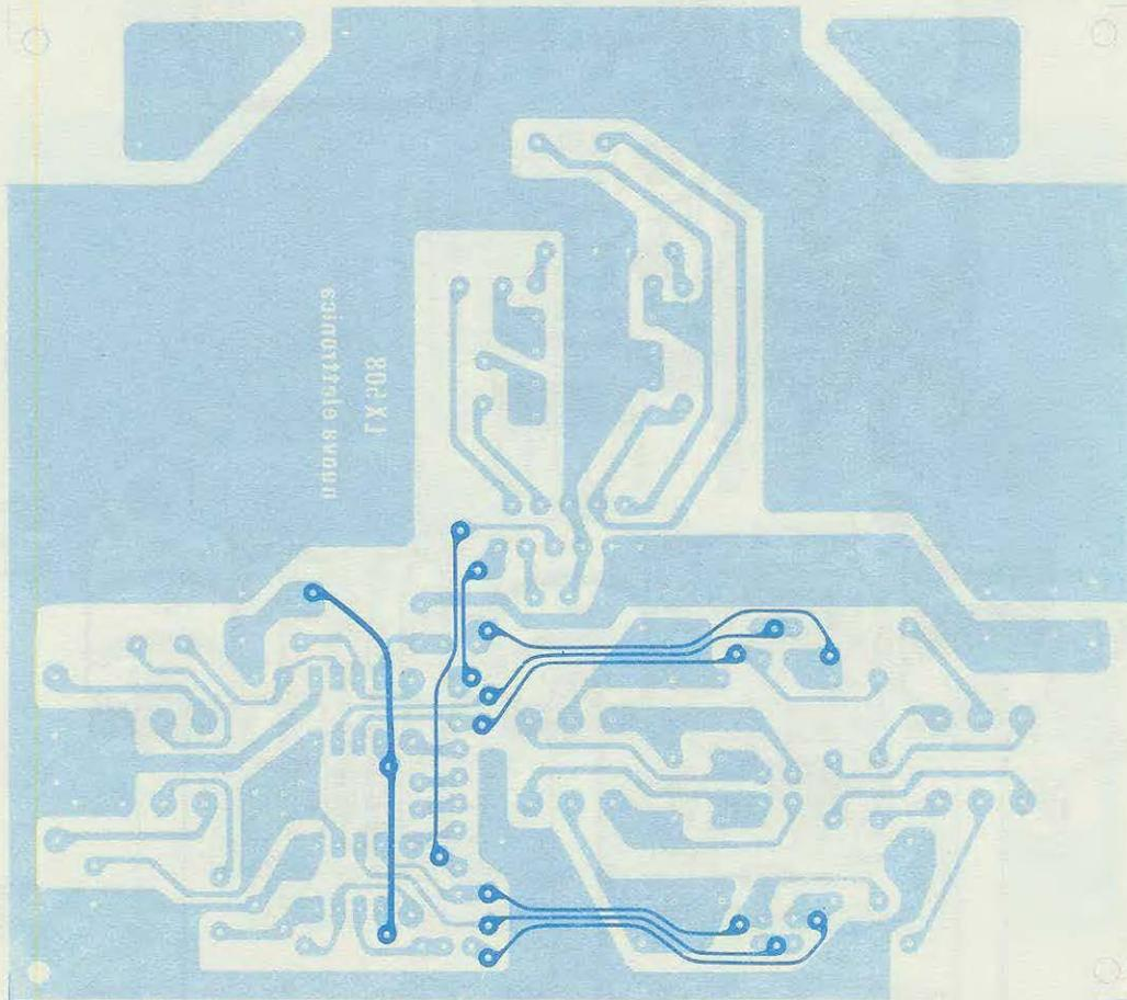
**Fig. 3** Disegno a grandezza naturale del circuito stampato. Questo circuito è un doppia faccia quindi dovremo ricordarci di stagnare i terminali delle piste superiori con quelle inferiori.
