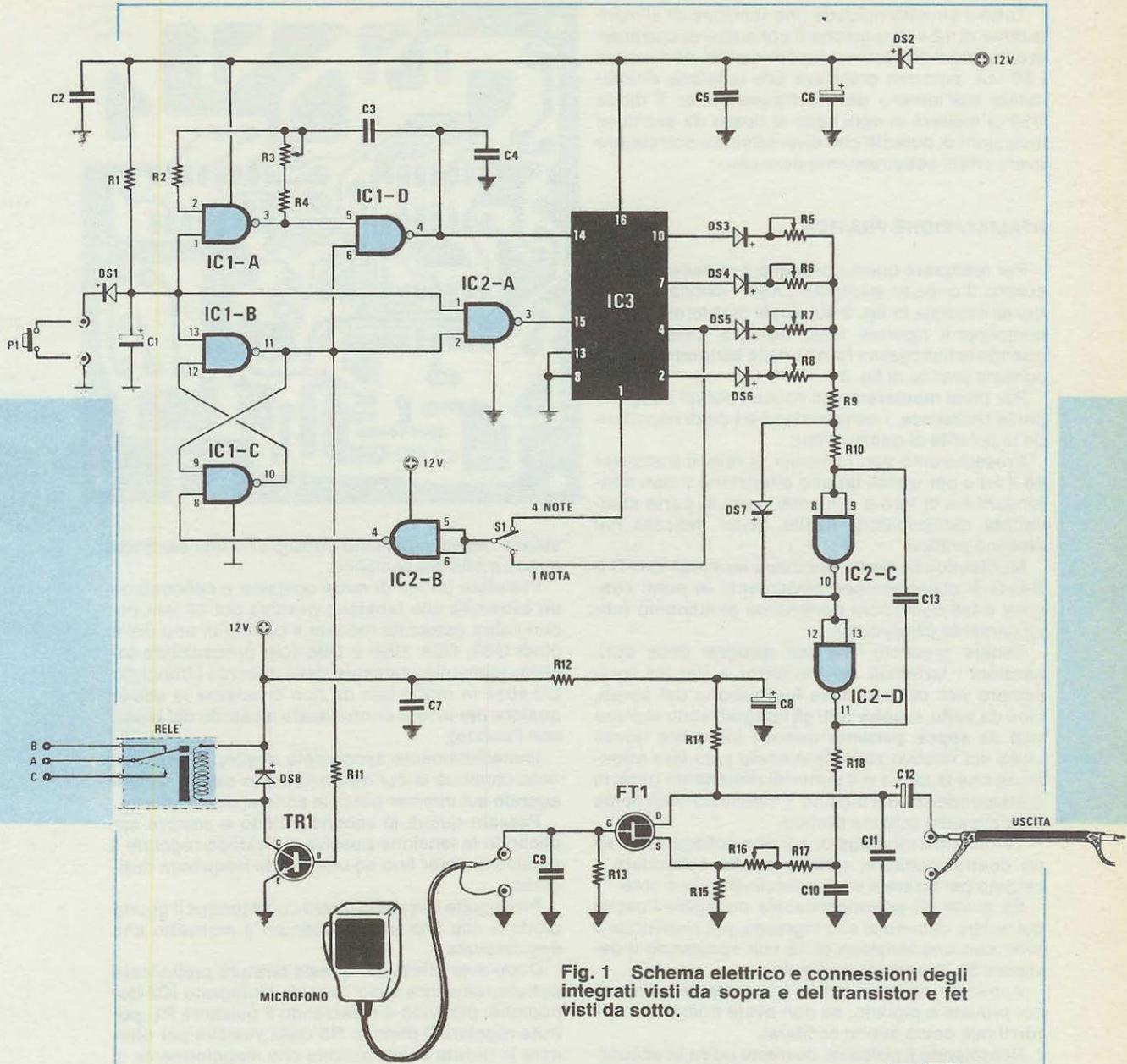
Fig. 1 Schema elettrico e connessioni degli integrati visti da sopra e del transistor e fet visti da sotto.
