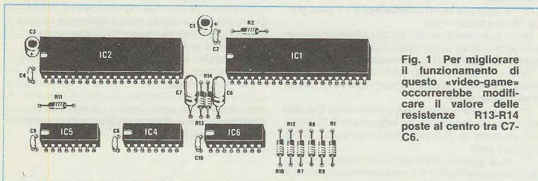
Fig. 1 Per migliorare il funzionamento di questo «video-game» occorrerebbe modificare il valore delle resistenze R13-R14 poste al centro tra C7-C6.
