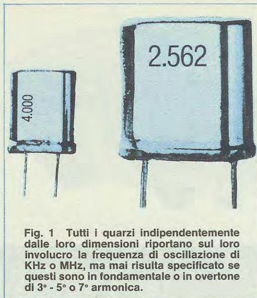
**Fig. 1** Tutti i quarzi indipendentemente dalle loro dimensioni riportano sul loro involucro la frequenza di oscillazione di KHz o MHz, ma mai risulta specificato se questi sono in fondamentale o in overtone di 3° - 5° o 7° armonica.
