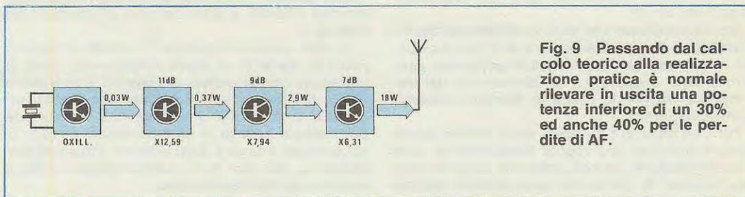
**Fig. 9** Passando dal calcolo teorico alla realizzazione pratica è normale rilevare in uscita una potenza inferiore di un 30% ed anche 40% per le perdite di AF.
