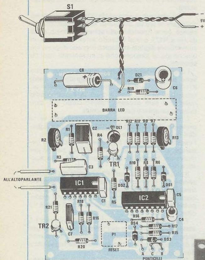
Fig. 5 Schema pratico di montaggio della clessidra. Sull'altro lato del circuito stampato troverà posto la barra a diodi led ed il pulsante P1. Nel disegno questi due componenti risultano tratteggiati.
