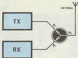
**Fig. 3** Se avessimo un ricevitore ed un trasmettitore da collegare alternativamente ad un'unica antenna è ovvio che il terminale P0 lo dovremo collegare all'antenna e i terminali P1 e P2 agli ingressi RX e TX.
