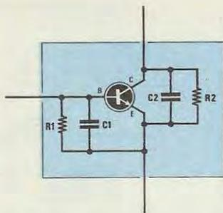
**Fig. 12** I valori di capacità e resistenza di Base e di capacità e resistenza di Collettore risultano quasi sempre riportati in configurazione «parallelo». A seconda del tipo di accoppiamento utilizzato questi valori a volte occorre convertirli da parallelo a «serie» vedi fig. 13.
