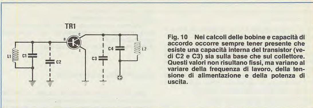
**Fig. 10** Nei calcoli delle bobine e capacità di accordo occorre sempre tener presente che esiste una capacità interna del transistor (vedi C2 e C3) sia sulla base che sul collettore. Questi valori non risultano fissi, ma variano al variare della frequenza di lavoro, della tensione di alimentazione e della potenza di uscita.
