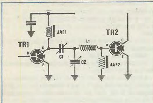
**Fig. 6** Per accoppiare due stadi amplificatori AF la schema più valido è quella di utilizzare questo filtro. In fig. 18 e 19 troveremo tutte le formule per calcolare i valori dei compensatore e delle bobine.
