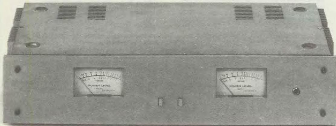
**Il mobile di questo amplificatore è della serie «Line Slim» cioè provvisto di pannello e alette laterali ossidate in colore «spaziale» con interno zincato color oro.
