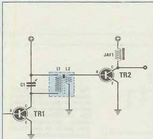
**Fig. 1** Per accoppiare uno stadio oscillatore ad un preamplificatore AF potremo direttamente collegare la bobina link L2 alla base del transistor. Così facendo non otterremo però il massimo trasferimento di energia da uno stadio all'altro.
