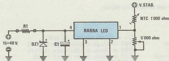
Fig. 3 Utilizzando una resistenza NTC da 1.000 ohm ed un trimmer da 5.000 ohm potremo realizzare un indicatore visivo di temperatura. Per alimentare la NTC è necessario utilizzare una tensione stabilizzata compresa tra 5-10 volt.
