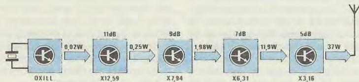
**Fig. 7** Se la potenza AF erogata dallo stadio oscillatore è irrisoria, occorreranno più stadi amplificatore AF per poter raggiungere la potenza desiderata. Conoscendo di ogni transistor amplificatore il Gpe espresso in dB., potremo calcolare in linea di massima la potenza che ricaveremo in uscita su ogni stadio.
