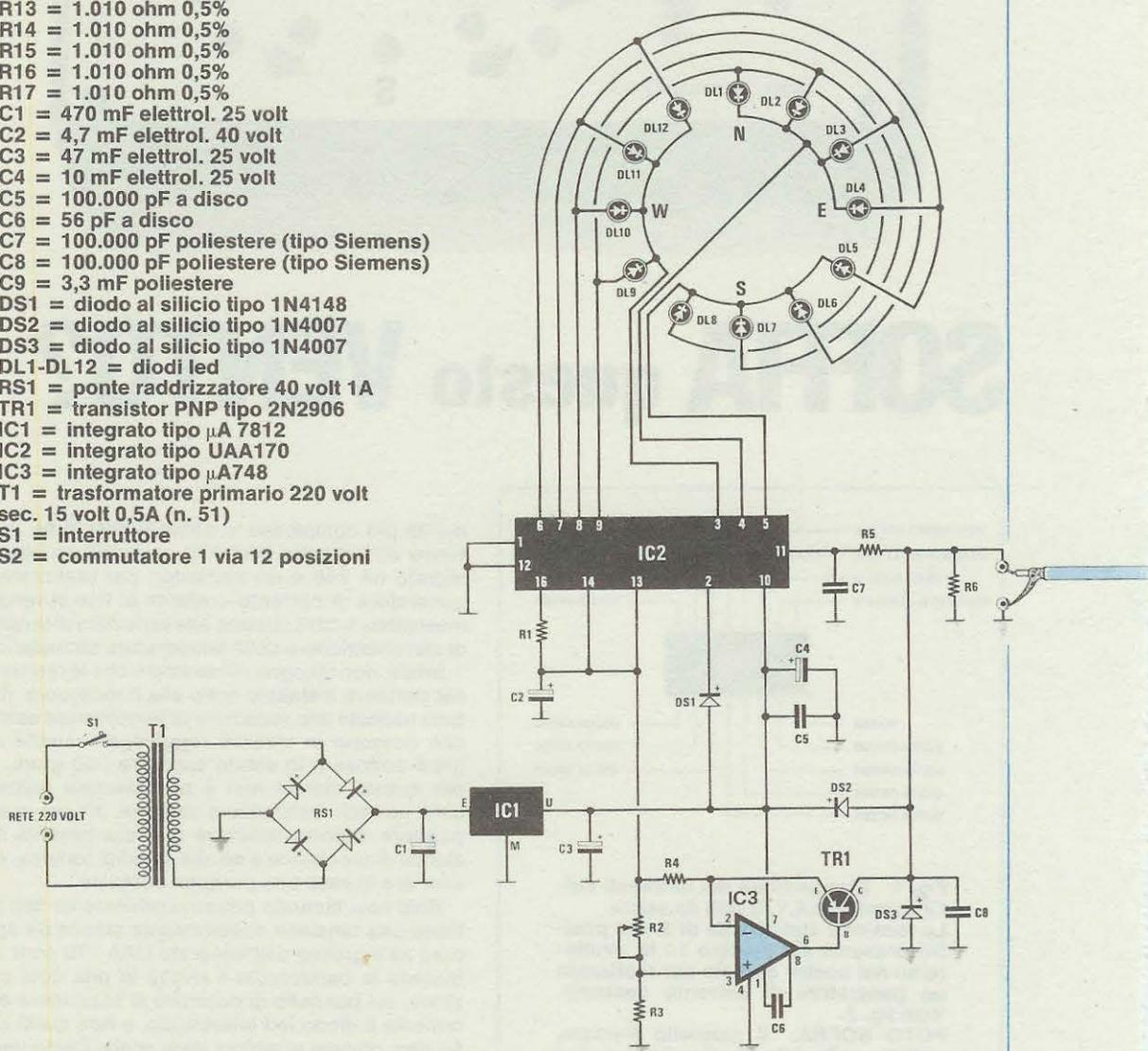
cheremo 11 resistenze di precisione ad alta stabilità termica da 1010 ohm.
