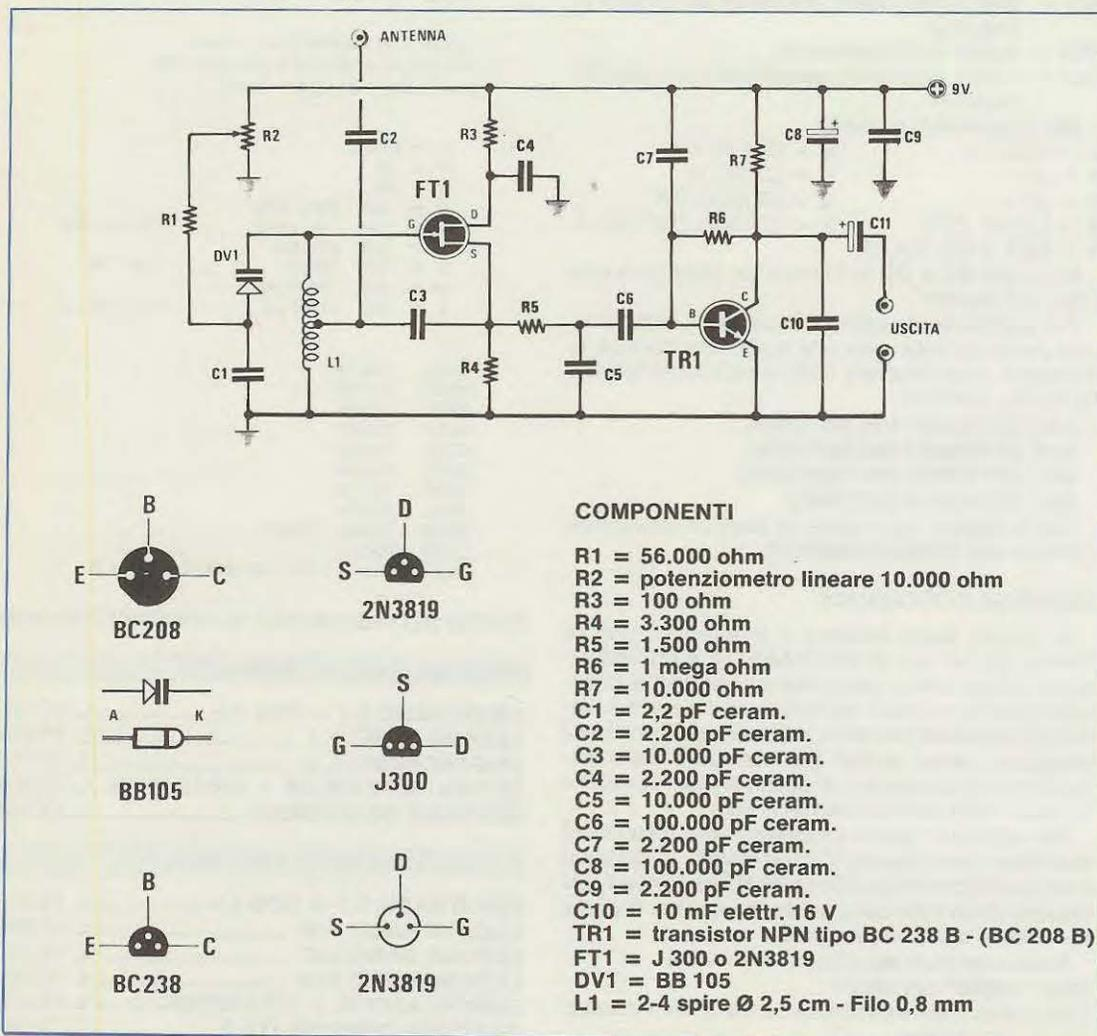
il condensatore C3 al terminale «source» del fet.
