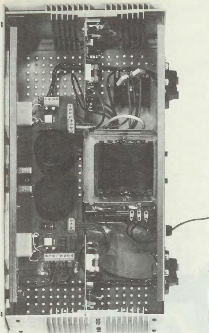
**Foto Sopra.** In questa foto si riesce meglio a distinguere la piccola aletta di raffreddamento sopra alla quale risulta fissato il ponte raddrizzatore di potenza RS1 e la piccola bassetta di ancoraggio provvista di tre terminali (fissata sul trasformatore di alimentazione) necessaria per i collegamenti del cordone di alimentazione 220 volt.
