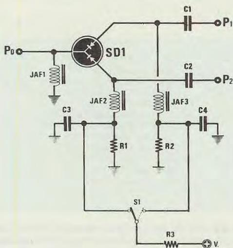
**Fig. 7** Per poter commutare P1 su P0 o P2 su P0 dovremo semplicemente applicare una tensione positiva sul terminale interessato. Il valore ohmico di R3 andrà scelto per far scorrere nei diodi circa 40-60 milliamper. Per le impedenze JAF e i condensatori C1 e C2 vedere i valori dello schema di fig. 8. Per R1-R2 potremo adottare 1.200-1.500 ohm mentre per C3-C4 dei condensatori ceramici VHF da 1.000 pF.
