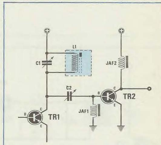
**Fig. 2** Anziché effettuare un accoppiamento induttivo come riportato in fig. 1, lo potremo effettuare capacitivo, collegando il collettore dell'oscillatore alla base del transistor preamplificatore, tramite un compensatore da 10/60 pF.
