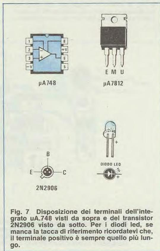
Fig. 7 Disposizione dei terminali dell'integrato uA.748 visti da sopra e del transistor 2N2906 visto da sotto. Per i diodi led, se manca la tacca di riferimento ricordatevi che, il terminale positivo è sempre quello più lungo.
