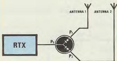
**Fig. 6** Un tale diodo lo potremo anche impiegare per commutare all'ingresso di un trasmettitore, due diverse antenne. In questo caso il terminale P0 lo dovremmo applicare sull'uscita del trasmettitore e i due terminali P1 e P2 alle due antenne.
