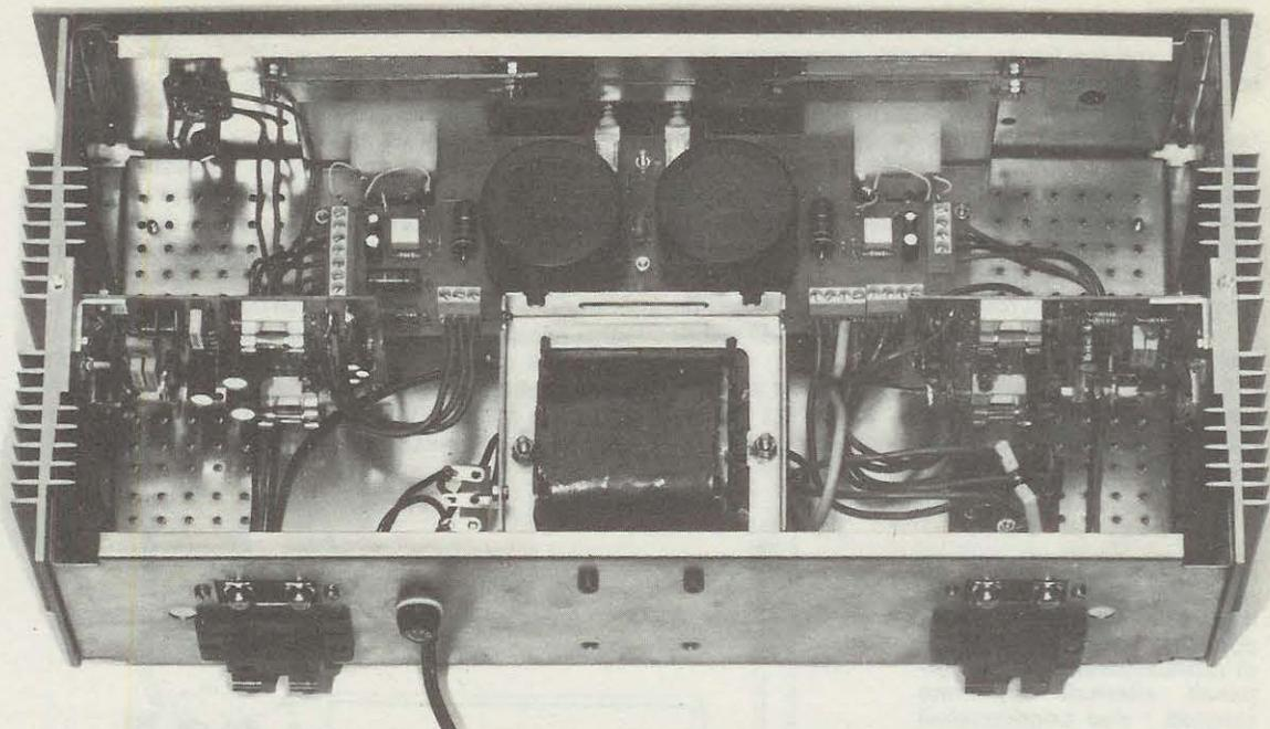
**In questa foto si possono vedere i due telai dell'amplificatore fissati lateralmente sulle due alette di raffreddamento. Si notino, come vengono fissati al contropannello del mobile, i due strumentini Vu-Meter.**
