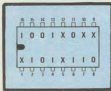
**Fig. 2** Se visualizziamo due file per 8, la disposizione delle condizioni logiche 1-0-X corrisponderanno esattamente con quelle dei piedini dell'integrato visto da sopra. Per gli integrati a 7 + 7 piedini sui due estremi appariranno sempre due X per i due piedini mancanti.
