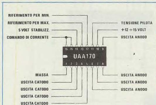
**Fig. 1** Disposizione dei terminali dell'integrato UAA.170 visti da sopra. La tensione stabilizzata di 5 volt positivi presente sul piedino 14 la sfrutteremo nel nostro circuito per realizzare un generatore di corrente costante. Vedi fig. 2.
