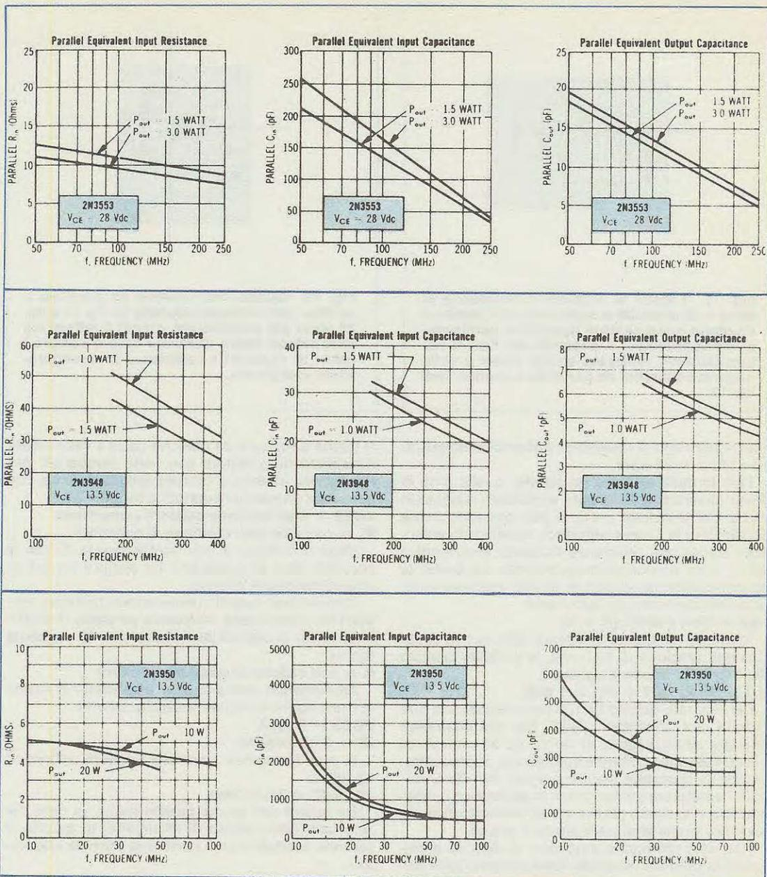
**Fig. 11** Per comprendere come possono variare queste capacità di base e di collettore al variare della frequenza di lavoro e della potenza erogata vi riportiamo i grafici di tre transistor. A sinistra è riportato il valore della resistenza di Base, al centro la capacità della Base e sulla destra la capacità di Collettore.
