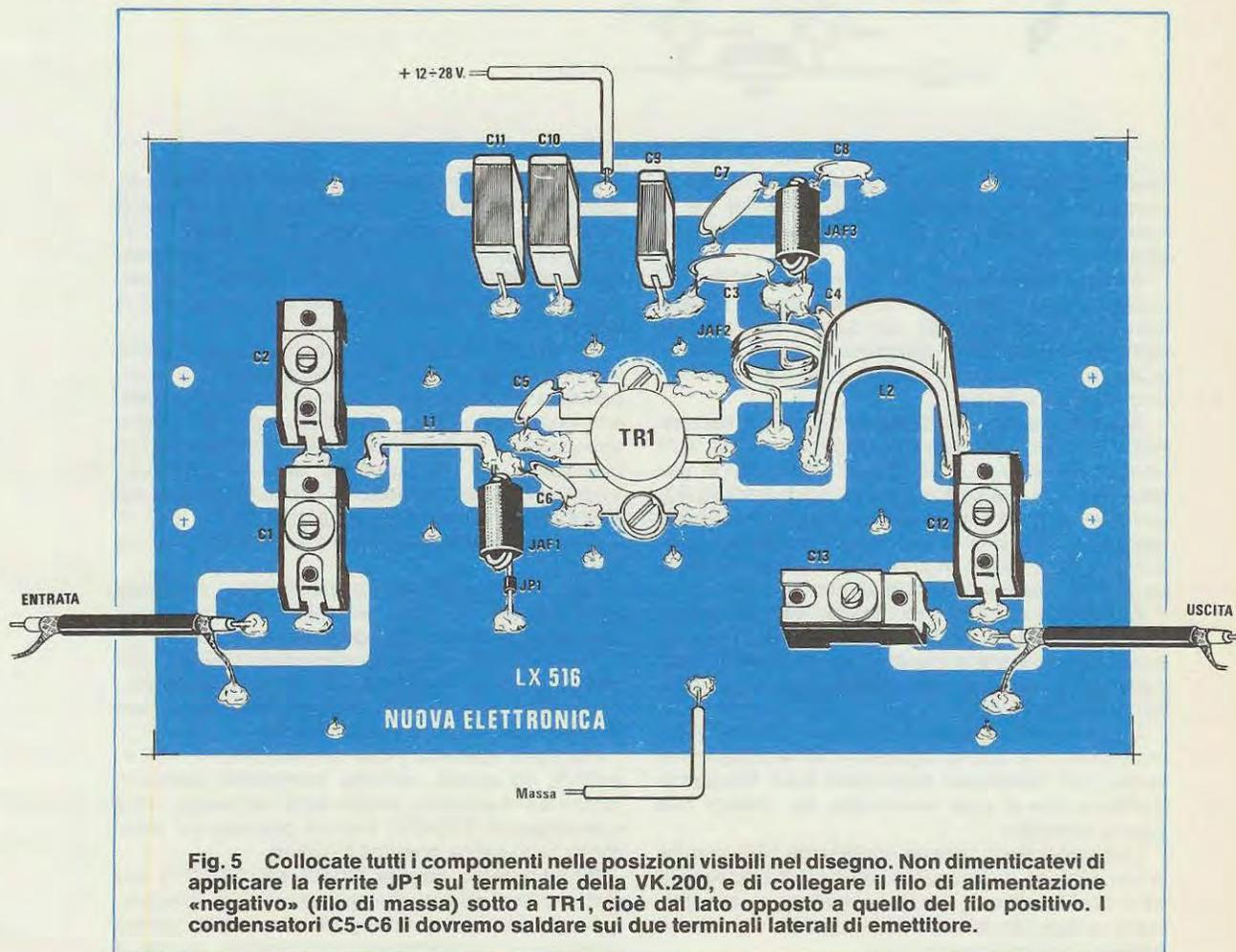
Fig. 5 Collocate tutti i componenti nelle posizioni visibili nel disegno. Non dimenticatevi di applicare la ferrite JP1 sul terminale della VK.200, e di collegare il filo di alimentazione «negativo» (filo di massa) sotto a TR1, cioè dal lato opposto a quello del filo positivo. I condensatori C5-C6 li dovremo saldare sui due terminali laterali di emettitore.
