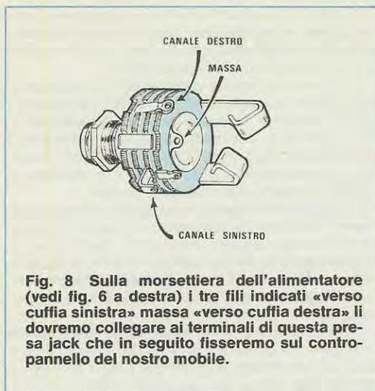
**Fig. 8 Sulla morsettiere dell'alimentatore (vedi fig. 6 a destra) i tre fili indicati «verso cuffia sinistra» massa «verso cuffia destra» li dovremo collegare ai terminali di questa presa jack che in seguito fisseremo sul controlpanello del nostro mobile.**
