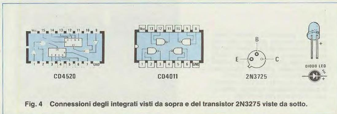
**Fig. 4** Connessioni degli integrati visti da sopra e del transistor 2N3275 viste da sotto.
