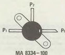
Fig. 1 Connessioni del diodo Switch. viste da sopra.
