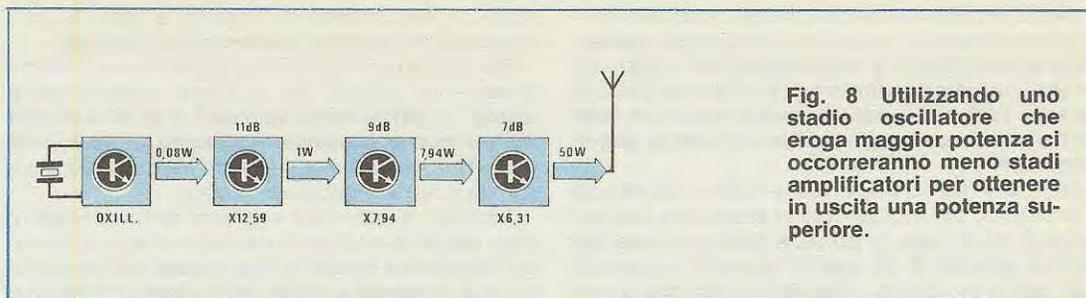
**Fig. 8** Utilizzando uno stadio oscillatore che eroga maggior potenza ci occorreranno meno stadi amplificatori per ottenere in uscita una potenza superiore.
