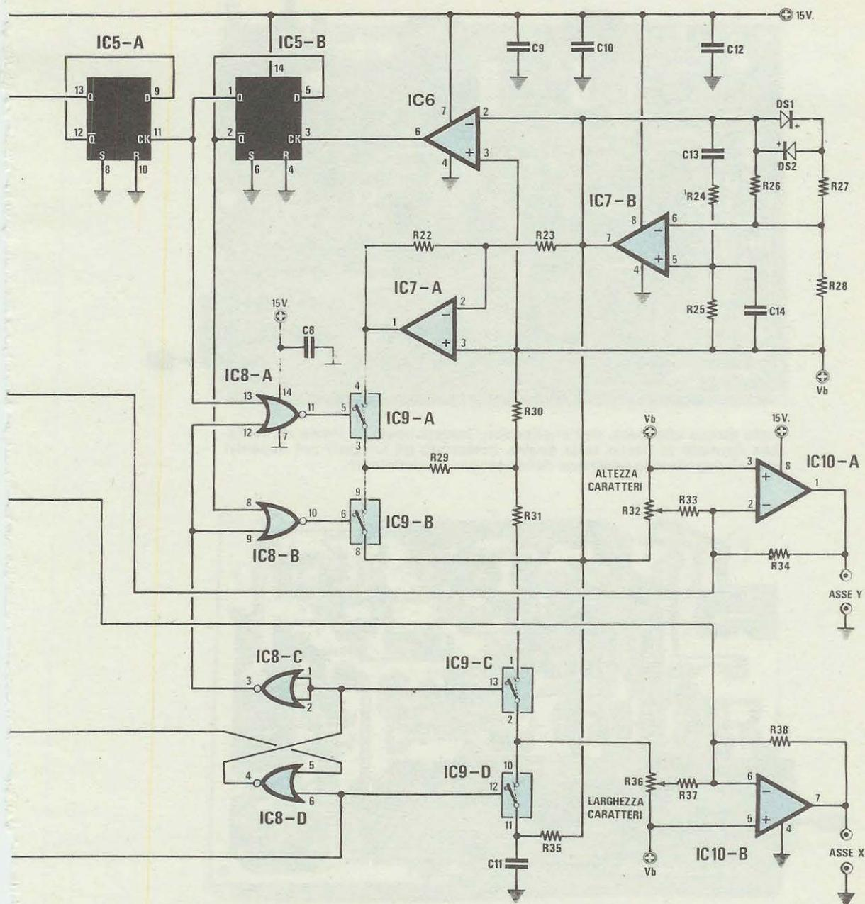
**Fig. 5** Schema elettrico dell'analizzatore grafico per integrati TTL e C.Mos. Sulla sinistra è visibile lo «zoccolo sonda» da innestare nel circuito sotto prova, e in alto lo zoccolo Textool entro al quale inseriremo l'integrato tolto da tale circuito. Come spiegato nell'articolo i terminali VP (visibili sulla sinistra) ci servono per prelevare la tensione di riferimento dal circuito di alimentazione sotto controllo. Per la lista componenti vedere la fig. 6 della pagina seguente.
