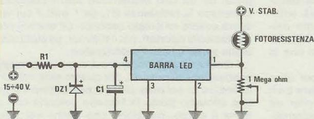
Fig. 1 Collegando all'ingresso di questa barra, una fotoresistenza alimentata con una tensione stabilizzata di 5-10 volt, realizzeremo un semplice esposimetro. Per i valori di R1-DZ1-C1 vedi fig. 5.
