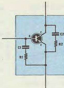
**Fig. 13** Questa conversione da parallelo a «serie» nelle formule riportate da fig. 14 a fig. 22 sono già considerate, quindi il lettore nei suoi calcoli dovrà utilizzare solo e sempre i valori di capacità e resistenza in configurazione «parallelo».
