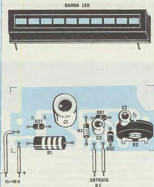
**Fig. 7** Schema pratico di montaggio del Vu-Meter. Dalla parte opposta di tale circuito fissaremo la barra a diodi led e poiché questa si inserirà solo nella sua giusta posizione, non dovremo preoccuparci dei quattro terminali presenti. Modificando il valore di R1 potremo alimentare questo circuito con qualsiasi tensione compresa tra 15 e i 40 volt. Per l'ingresso BF ricordatevi che uno dei due fili è di massa.
