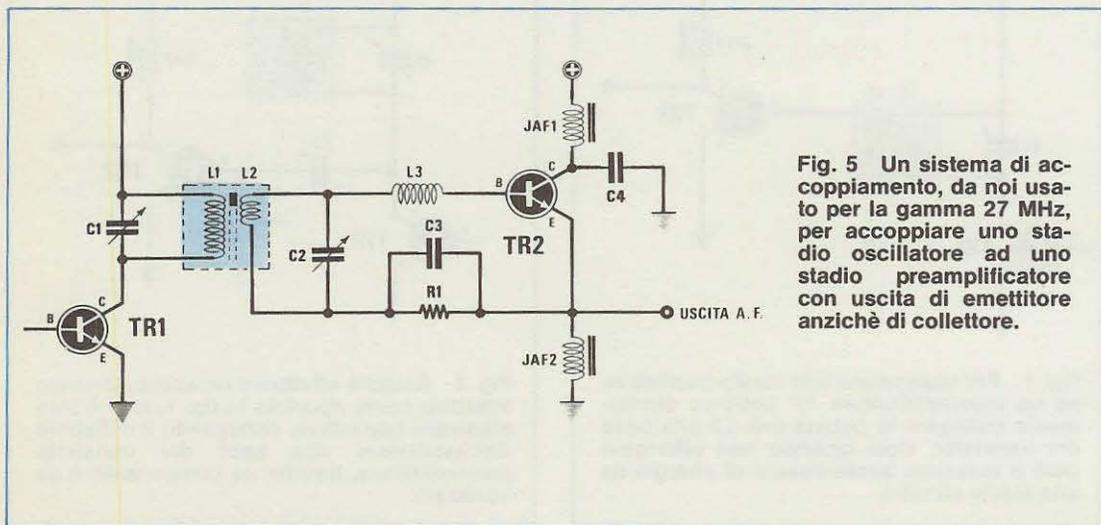
Fig. 5 Un sistema di accoppiamento, da noi usato per la gamma 27 MHz, per accoppiare uno stadio oscillatore ad uno stadio preamplificatore con uscita di emettitore anziché di collettore.
