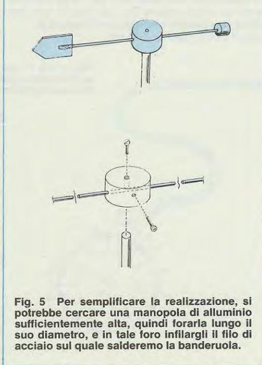
Fig. 5 Per semplificare la realizzazione, si potrebbe cercare una manopola di alluminio sufficientemente alta, quindi forarla lungo il suo diametro, e in tale foro infilarli il filo di acciaio sul quale salderemo la banderuola.
