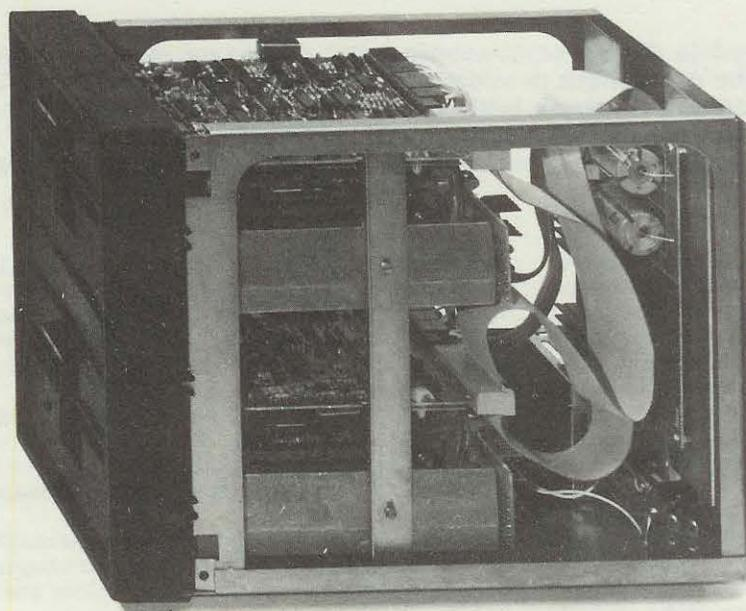
Dal connettore maschio fissato sul pannello posteriore fisseremo la piastrina necessaria per pilotare i due drive-floppy. Le dimensioni di questo mobile sono identiche a quelle del monitor Video LX.599, così dicasi per il colore e della mascherina in plastica antiurto.
