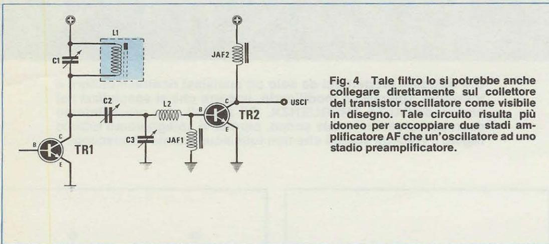
Fig. 4 Tale filtro lo si potrebbe anche collegare direttamente sul collettore del transistor oscillatore come visibile in disegno. Tale circuito risulta più idoneo per accoppiare due stadi amplificatore AF che un'oscillatore ad uno stadio preamplificatore.
