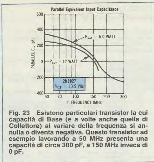
**Fig. 23** Esistono particolari transistor la cui capacità di Base (e a volte anche quella di Collettore) al variare della frequenza si annulla o diventa negativa. Questo transistor ad esempio lavorando a 50 MHz presenta una capacità di circa 300 pF, a 150 MHz invece di 0 pF.
