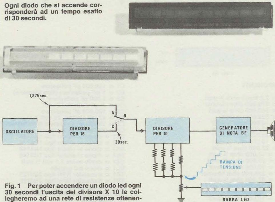
Fig. 1 Per poter accendere un diodo led ogni 30 secondi l'uscita del divisore X 10 le collegheremo ad una rete di resistenze ottenendo così un convertitore analogico digitale in grado di generare una rampa la cui tensione aumenta di un gradino ogni 30 secondi.
