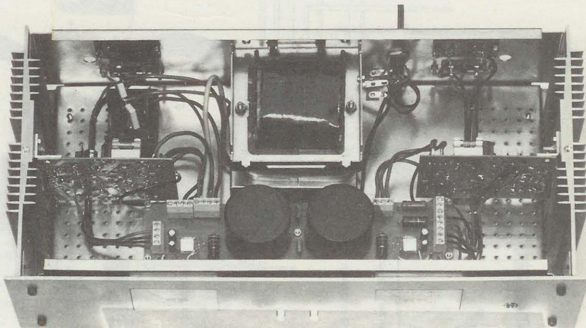
**Il trasformatore di alimentazione verrà collocato orizzontalmente e fissato con due viti sul pannello posteriore. E consigliabile tenere i fili di uscita in basso. Il circuito stampato dell'alimentatore verrà posto frontalmente al trasformatore come risulta visibile in queste due foto.**
