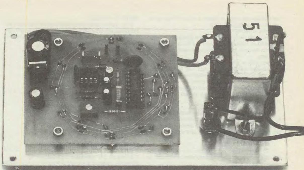
Il circuito stampato lo dovremo fissare sotto al pannello frontale del mobile, tenendolo distanziato di qualche millimetro per evitare che qualche terminale non vada a toccare il metallo del pannello. Il trasformatore di alimentazione lo fissaremo con due viti sul lato destro.
