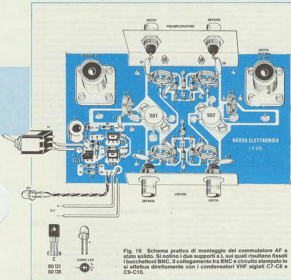
Fig. 10 Schema pratico di montaggio del commutatore AF a stato solido. Si notino i due supporti a L sui quali risultano fissati i bocchettoni BNC. Il collegamento tra BNC e circuito stampato lo si effettua direttamente con i condensatori VHF siglati C7-C8 e C9-C10.
