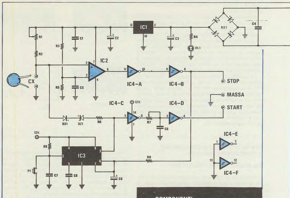
Se la differenza di potenziale ai capi di CX si annullasse, l'integrato IC2 si interdirebbe con conseguenti ritardi e anomalie di funzionamento.
