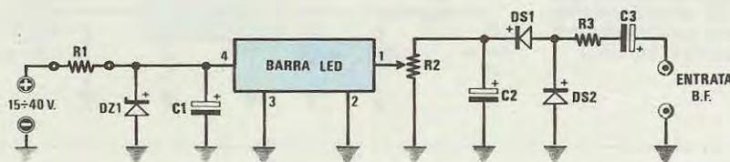
**Fig. 5** Schema elettrico del circuito Vu-Meter.
