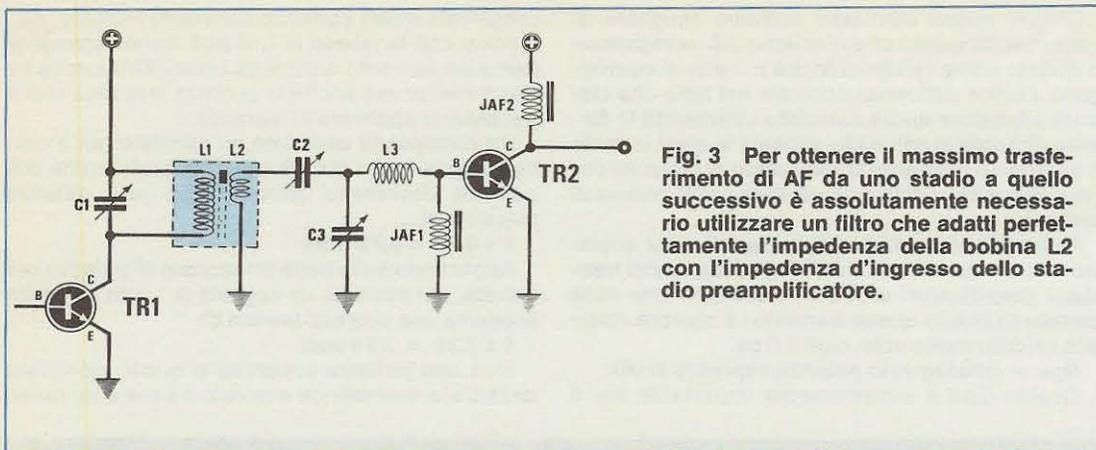
Fig. 3 Per ottenere il massimo trasferimento di AF da uno stadio a quello successivo è assolutamente necessario utilizzare un filtro che adatti perfettamente l'impedenza della bobina L2 con l'impedenza d'ingresso dello stadio preamplificatore.
