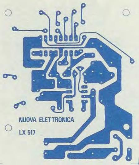
Fig. 6 Disegno a grandezza naturale del circuito stampato necessario per questa realizzazione.
