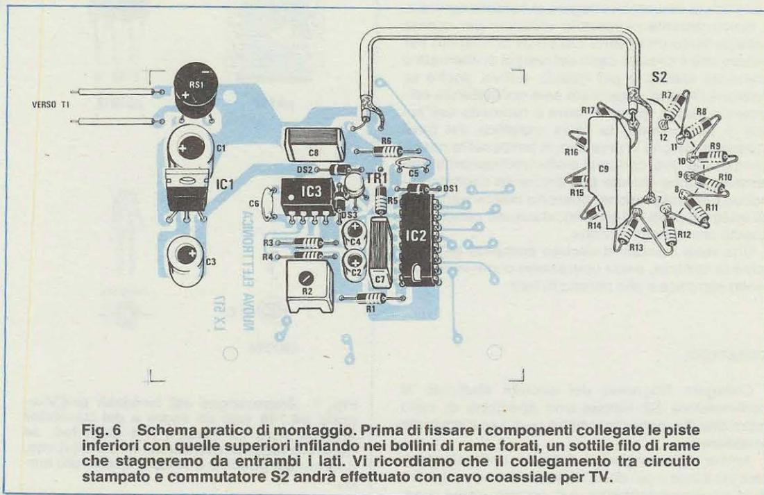
Fig. 6 Schema pratico di montaggio. Prima di fissare i componenti collegate le piste inferiori con quelle superiori infilando nei bollini di rame forati, un sottile filo di rame che stagneremo da entrambi i lati. Vi ricordiamo che il collegamento tra circuito stampato e commutatore S2 andrà effettuato con cavo coassiale per TV.
