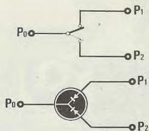
**Fig. 2** Il sistema più semplice per capire come utilizzare questo commutatore elettronico è quello di considerarlo un normale deviatore a levetta, dove P0 potrebbe corrispondere al terminale centrale di commutazione.
