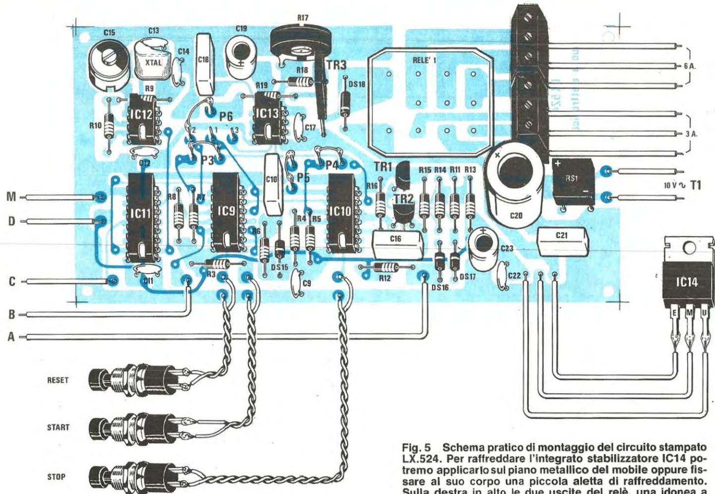
Fig. 5 Schema pratico di montaggio del circuito stampato LX.524. Per raffreddare l'integrato stabilizzatore IC14 potremo applicarlo sul piano metallico del mobile oppure fissare al suo corpo una piccola aletta di raffreddamento. Sulla destra in alto le due uscite del relè, una idonea a sopportare una corrente di 6 amper e l'altra di 3 amper.
