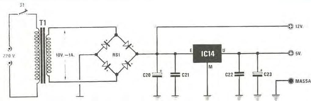
**Fig. 2** Schema elettrico dell'alimentatore. Questo stadio trova posto sul circuito stampato LX.524 visibile in asso sulla destra.
