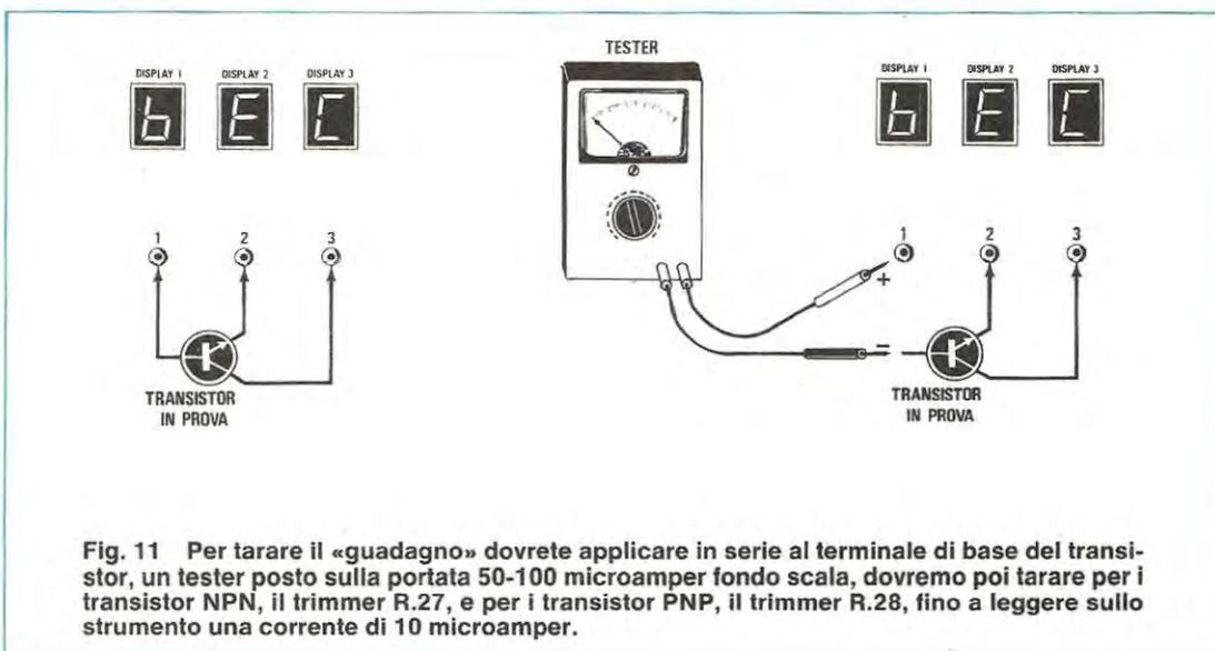
Fig. 11 Per tarare il «guadagno» dovrete applicare in serie al terminale di base del transistor, un tester posto sulla portata 50-100 microamper fondo scala, dovremo poi tarare per i transistor NPN, il trimmer R.27, e per i transistor PNP, il trimmer R.28, fino a leggere sullo strumento una corrente di 10 microamper.
