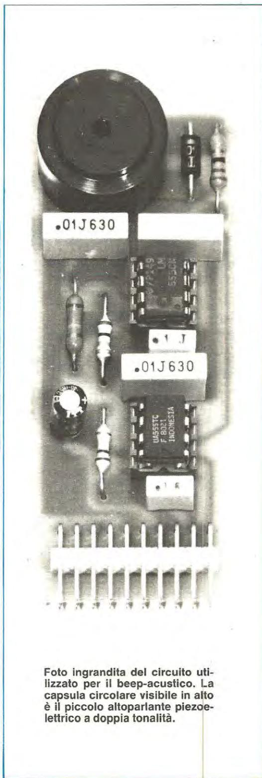
Foto ingrandita del circuito utilizzato per il beep-acustico. La capsula circolare visibile in alto è il piccolo altoparlante piezoelettrico a doppia tonalità.
