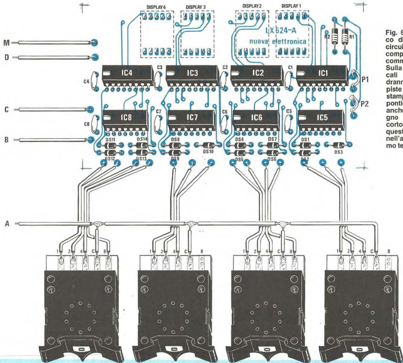
Fig. 6 Schema pratico di montaggio del circuito LX.524-A completo dei quattro commutatori binari. Sulla destra, i fili indicati M-D-C-B-A andranno collegati alle piste del circuito stampato di fig. 5. I ponticelli da P1 a P6, anche se in tale disegno li abbiamo tutti cortocircuitati, molti di questi, come spiegato nell'articolo, li dovremo tenere aperti.
