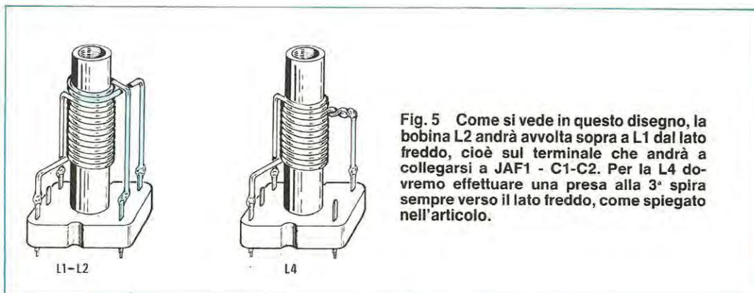
Fig. 5 Come si vede in questo disegno, la bobina L2 andrà avvolta sopra a L1 dal lato freddo, cioè sul terminale che andrà a collegarsi a JAF1 - C1-C2. Per la L4 dovremo effettuare una presa alla 3ª spira sempre verso il lato freddo, come spiegato nell'articolo.
