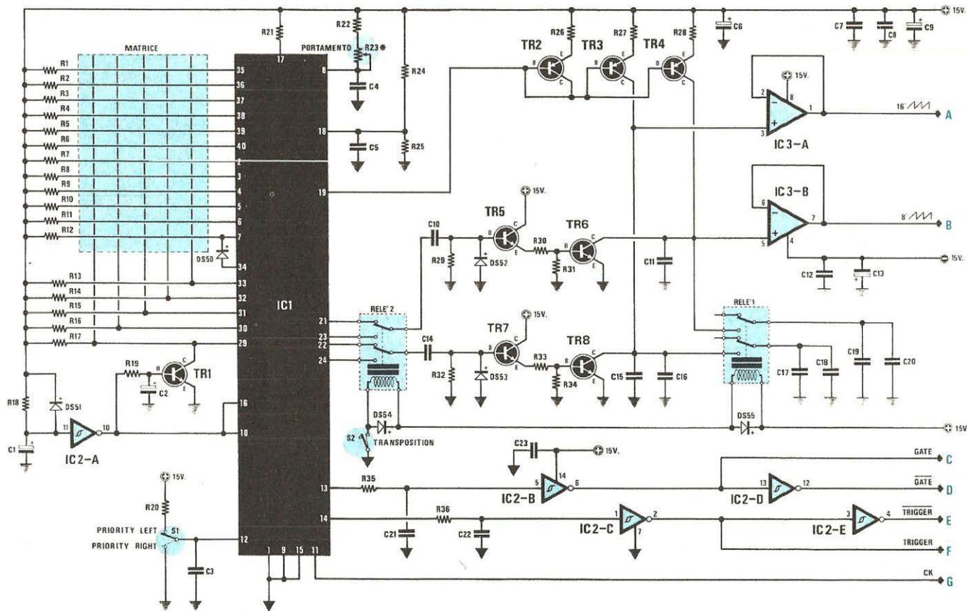
Fig. 2 La parte più complessa di un synthesizer è il generatore di involuipo, che nel nostro progetto risulta notevolmente semplificato avendo utilizzato per questa funzione un apposito integrato siglato M.110 (vedi IC1). In alto la lista componenti di questo stadio. Nota = I terminali indicati con le lettere A-B-C ecc. visibili in colore sulla destra dello schema elettrico andranno a congiungersi con i terminali corrispondenti agli schemi successivi.
