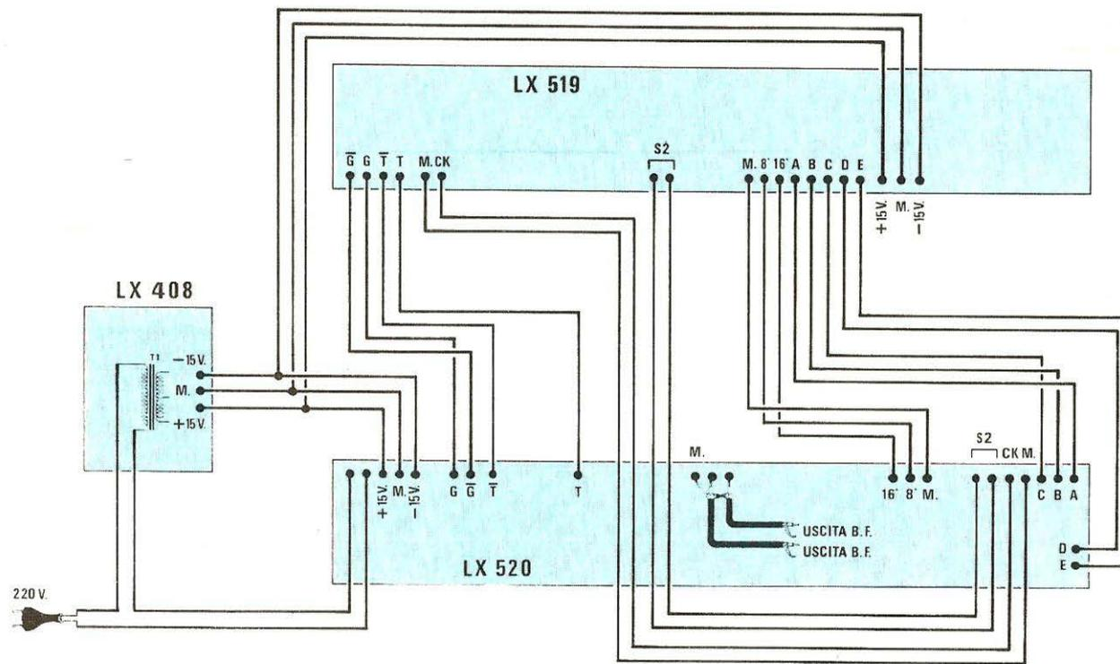
**Fig. 15** I due circuiti stampati LX.519 e LX.520 dovranno essere collegati tra di loro utilizzando dei normali fili di rame isolati in plastica. In questo disegno abbiamo riportato i diversi terminali, indicati con le lettere e i numeri che saranno serigrafati sui due circuiti stampati.
