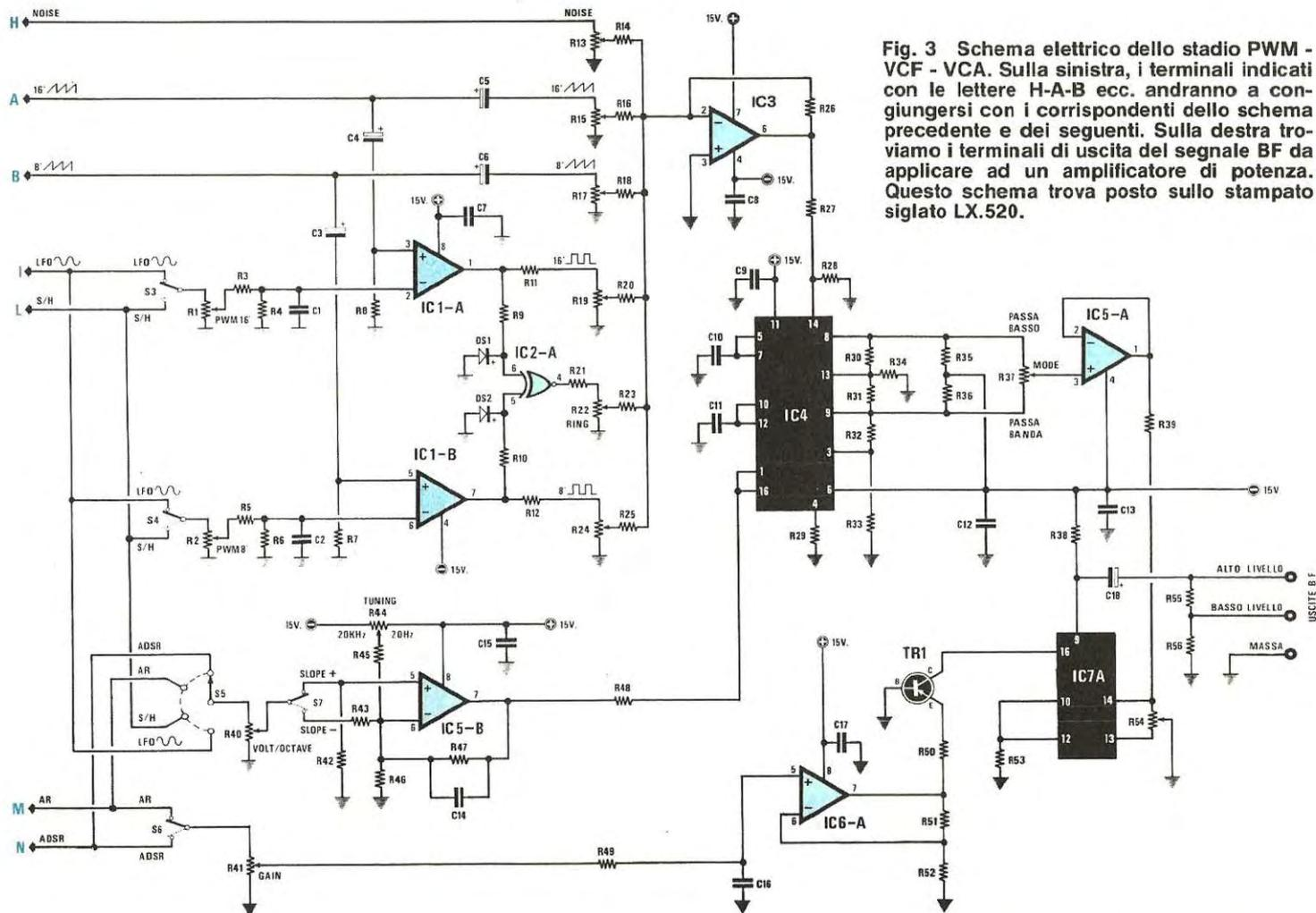
Fig. 3 Schema elettrico dello stadio PWM - VCF - VCA. Sulla sinistra, i terminali indicati con le lettere H-A-B ecc. andranno a congiungersi con i corrispondenti dello schema precedente e dei seguenti. Sulla destra troviamo i terminali di uscita del segnale BF da applicare ad un amplificatore di potenza. Questo schema trova posto sullo stampato siglato LX.520.
