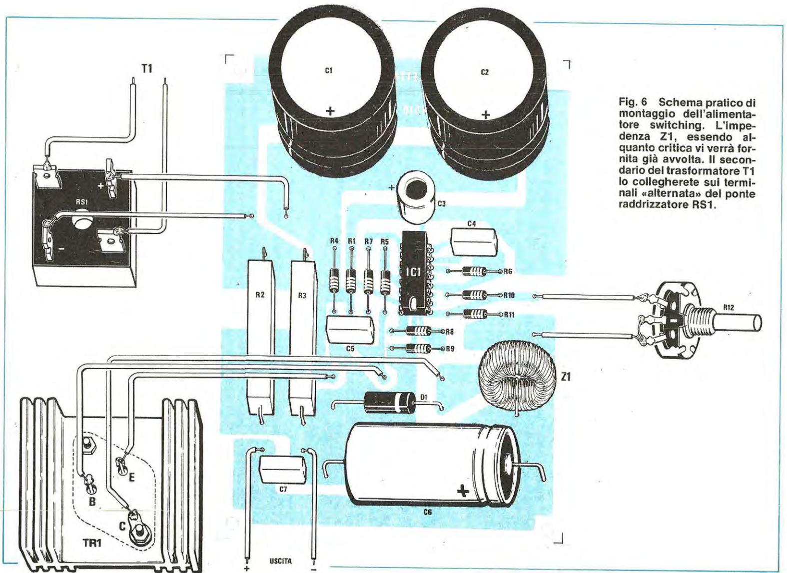
Fig. 6 Schema pratico di montaggio dell'alimentatore switching. L'impedenza Z1, essendo alquanto critica vi verrà fornita già avvolta. Il secondario del trasformatore T1 lo collegherete sui terminali «alternata» del ponte raddrizzatore RS1.
