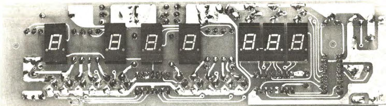
Foto del circuito di visualizzazione visto dal lato dei display. Inserendo i display sul circuito stampato, controllate che il punto decimale di questi risultati collocato verso il basso come visibile nella foto.
