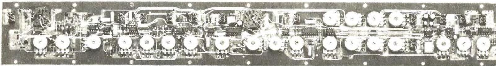
**Fig. 14** Anche il circuito stampato LX.520 risulta lungo quanto il circuito LX.519. Su tale circuito come vedesi in questa foto troveranno posto tutti i potenziometri, i deviatori e commutatori rotativi. Questo circuito stampato andrà fissato sotto il pannello frontale che vi verrà fornito già forato e serigrafato.
