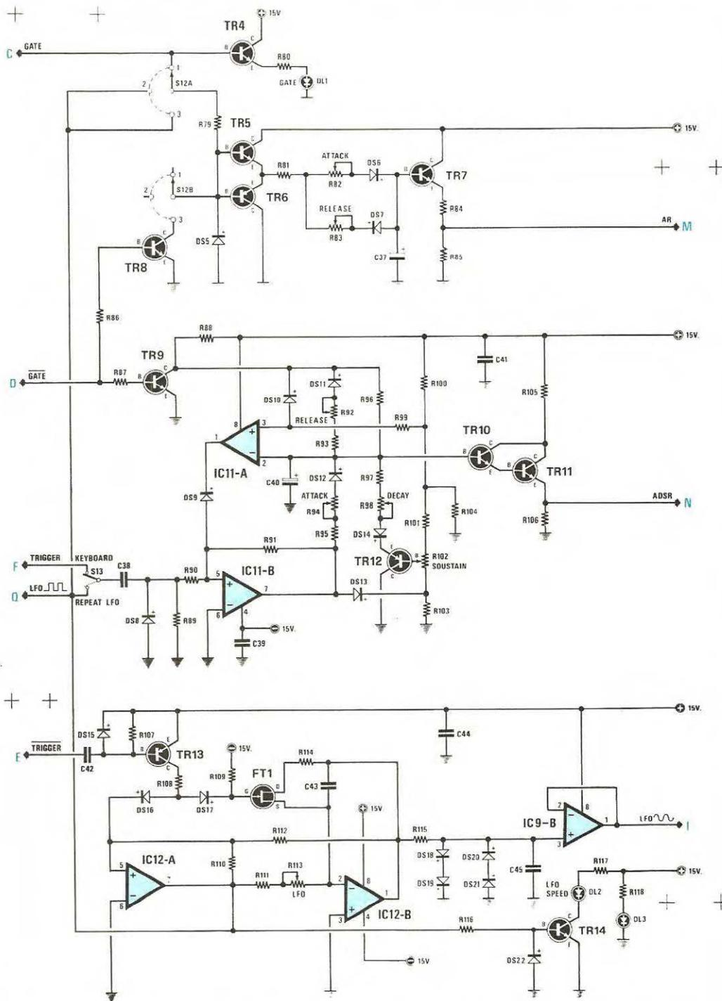
Fig. 6 Schema elettrico dello stadio A/R - LFO - ADSR. Anche questo stadio, come i precedenti, verrà montato sul circuito stampato LX.520.
