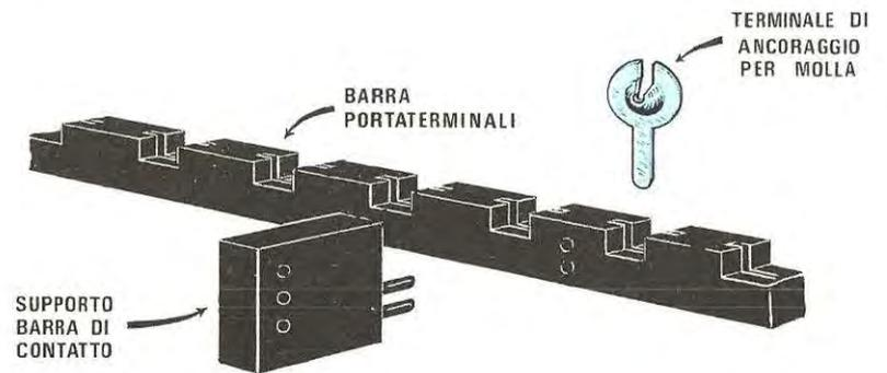
Fig. 8 Nelle fessure presenti sulla barra portaterminali in plastica infilerete i terminali di ancoraggio per le molle di contatto. Sul lato anteriore di tale barra, innesterete i supporti necessari per sostenere la barra di contatto che andrà infilata nel foro centrale.
