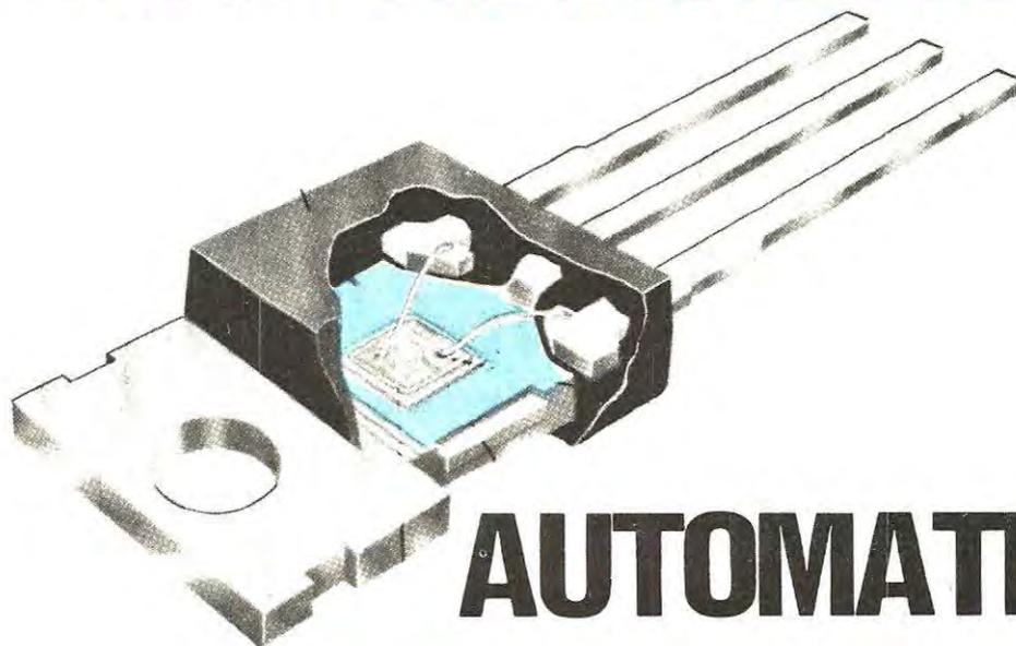
Inserendo qualsiasi transistor con i terminali disposti casualmente, questo strumento vi indicherà qual'è il terminale di collettore, quello di base e quello di emettitore, non solo ma vi preciserà anche se il transistor è un PNP o un NPN e automaticamente vi informerà visualizzandolo su un display, il relativo guadagno.
