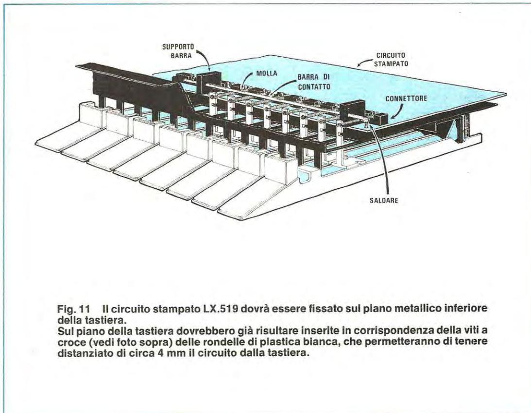
**Fig. 11** Il circuito stampato LX.519 dovrà essere fissato sul piano metallico inferiore della tastiera. Sul piano della tastiera dovrebbero già risultare inserite in corrispondenza della viti a croce (vedi foto sopra) delle rondelle di plastica bianca, che permetteranno di tenere distanziato di circa 4 mm il circuito dalla tastiera.
