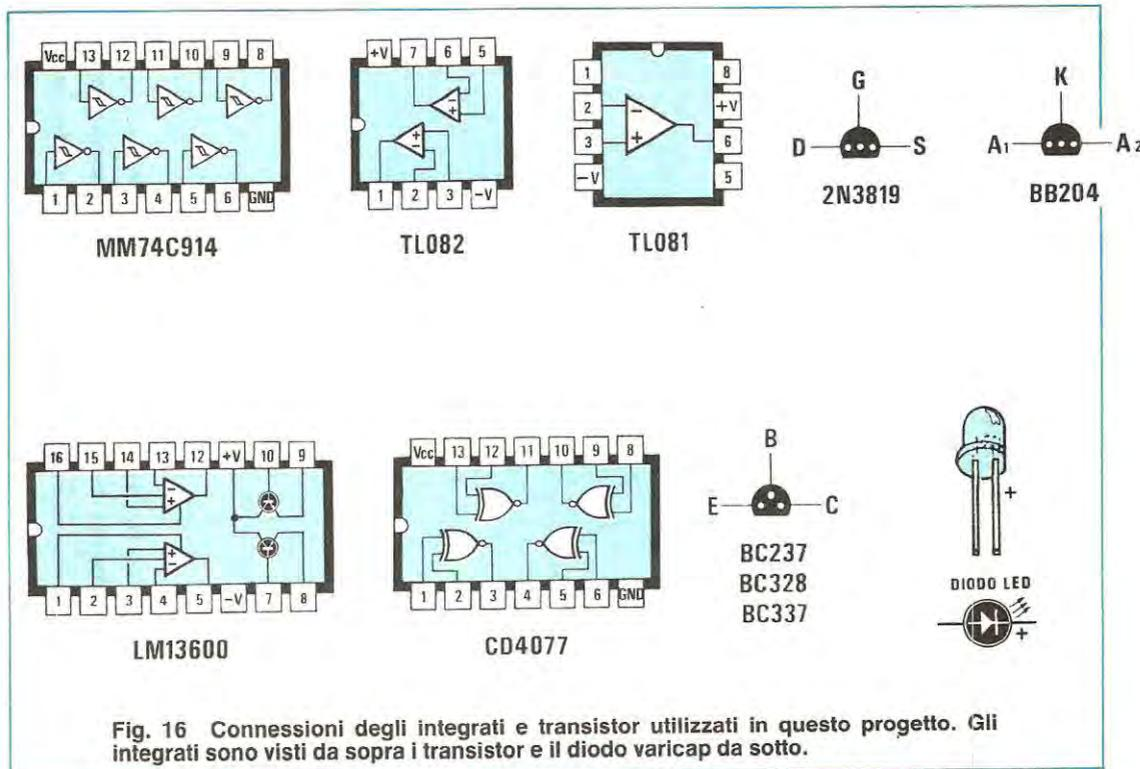
Fig. 16 Connessioni degli integrati e transistor utilizzati in questo progetto. Gli integrati sono visti da sopra i transistor e il diodo varicap da sotto.
