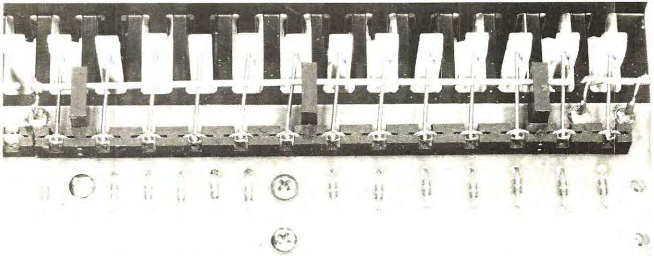
**Fig. 10** In questa foto è chiaramente visibile la barra portaterminali con le mollettine già agganciate con una estremità sui terminali di ancoraggio e l'altra sui tasti della tastiera. Controllate, dopo aver infilato le mollettine, se pigiando i tasti queste vadano a toccare la barra di contatto.
