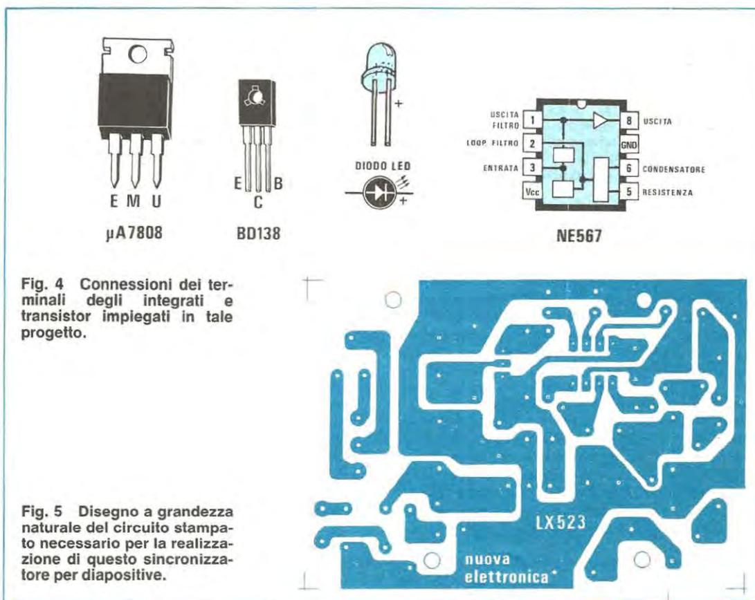
Fig. 4 Connessioni dei terminali degli integrati e transistor impiegati in tale progetto.
