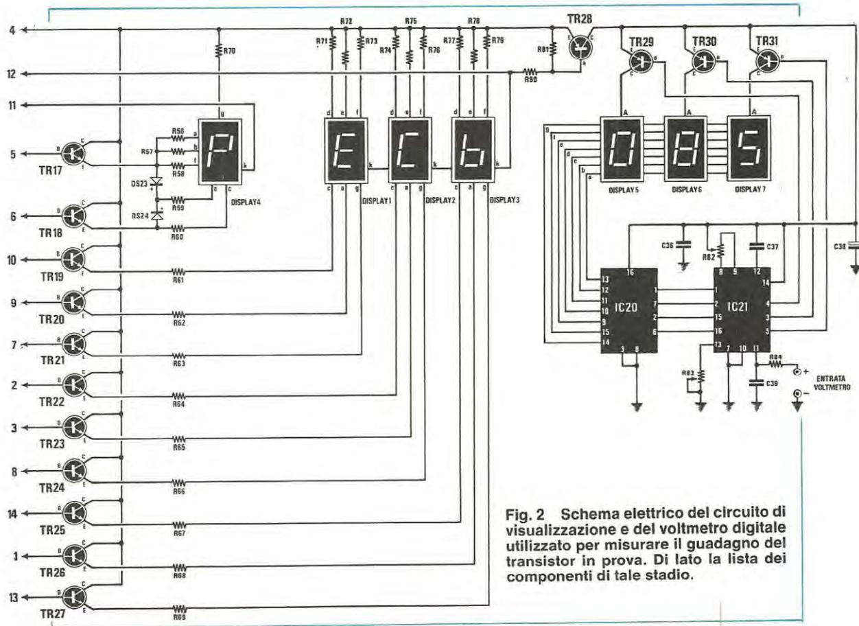
Fig. 2 Schema elettrico del circuito di visualizzazione e del voltmetro digitale utilizzato per misurare il guadagno del transistor in prova. Di lato la lista dei componenti di tale stadio.
