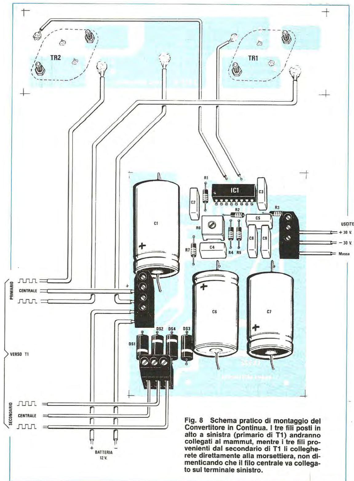
**Fig. 8** Schema pratico di montaggio del Convertitore in Continuo. I tre fili posti in alto a sinistra (primario di T1) andranno collegati al mammut, mentre i tre fili provenienti dal secondario di T1 li collegherete direttamente alla morsettiera, non dimenticando che il filo centrale va collegato sul terminale sinistro.
