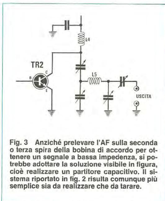
**Fig. 3** Anziché prelevare l'AF sulla seconda o terza spira della bobina di accordo per ottenere un segnale a bassa impedenza, si potrebbe adottare la soluzione visibile in figura, cioè realizzare un partitore capacitivo. Il sistema riportato in fig. 2 risulta comunque più semplice sia da realizzare che da tarare.
