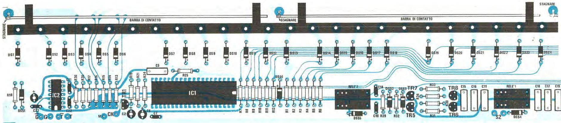
Fig. 7 Non potendo inserire sulla rivista il disegno a grandezza naturale del circuito stampato LX.519, lo abbiamo ridotto e suddiviso in due parti: qui sopra abbiamo riportato la parte sinistra e nella fig. 9 della pagina accanto in basso, la parte destra. Notate le barre di contatto di filo argentato che dovranno risultare lunghe quanto basta per servire 12 tasti. L'estremità sinistra di tali barre andranno collegate sul terminale che fuoriesce da questo lato sul circuito stampato.
