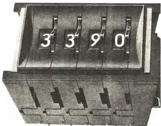
Fig. 6 I quattro commutatori binari raggruppati in un unico blocco e fissati sul pannello frontale ci permetteranno di scegliere il tempo in minuti o secondi cui desideriamo far eccitare il relè.
