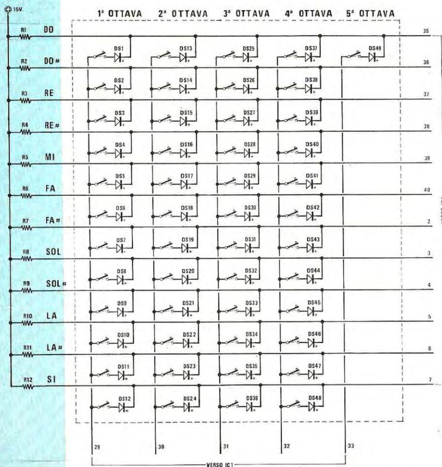
Fig. 1 Schema elettrico della matrice della tastiera a 4 ottave + DO (della 5° ottava) che si collegherà agli ingressi dell'integrato IC1 come riportato in fig. 2.
