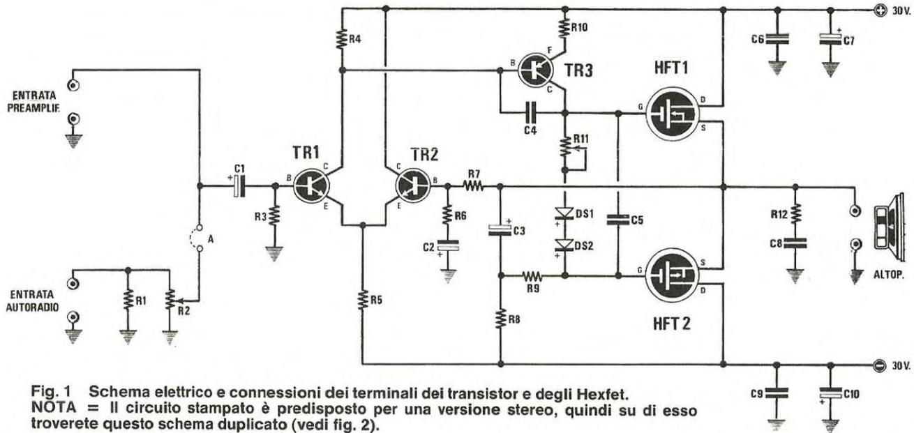
Fig. 1 Schema elettrico e connessioni dei terminali dei transistor e degli Hexfet.
