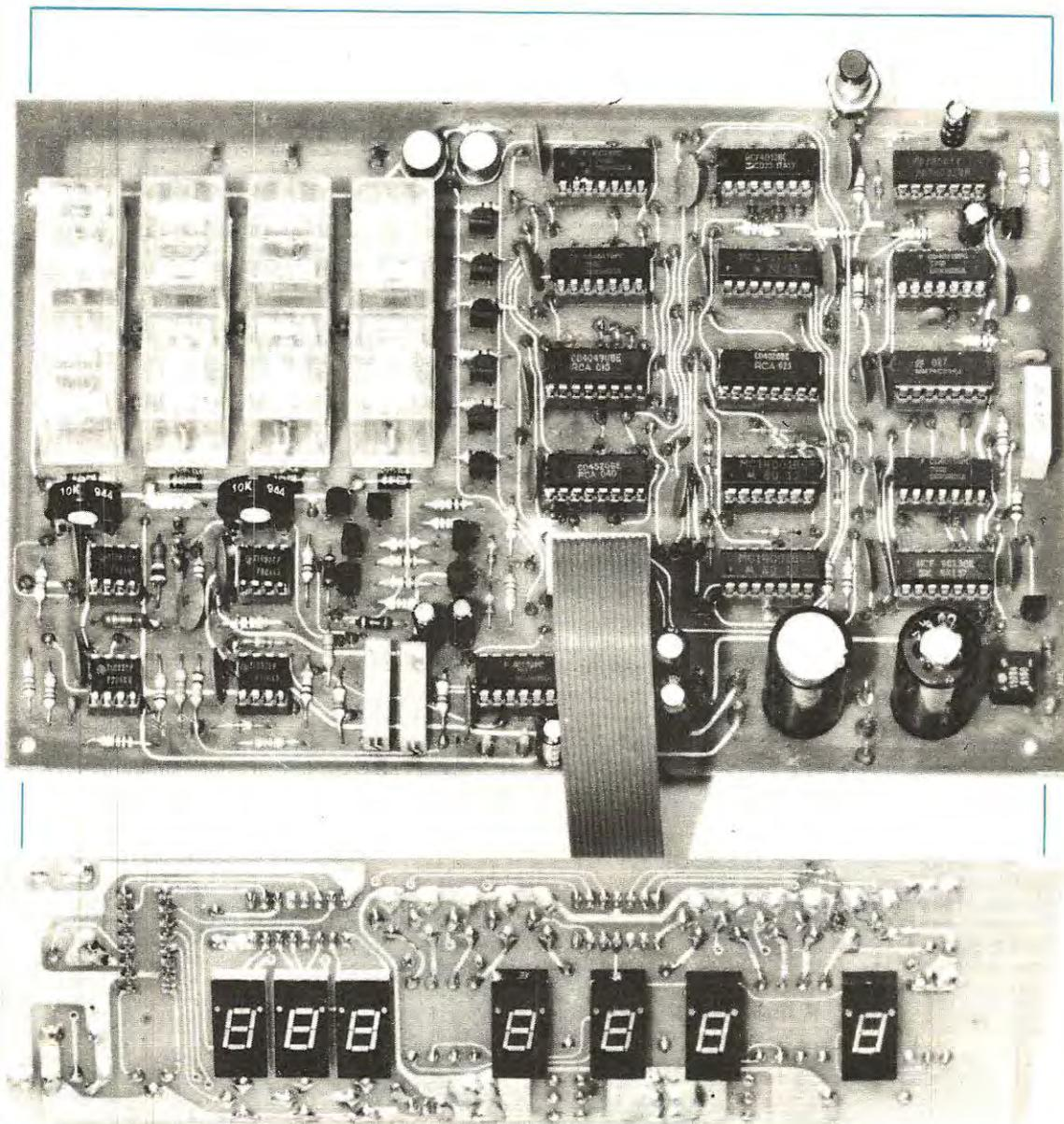
**Questo è il primo ed unico provatransistor in grado di individuare automaticamente la disposizione dei terminali E-B-C di qualsiasi transistor, di indicarne la polarità e il beta.**
