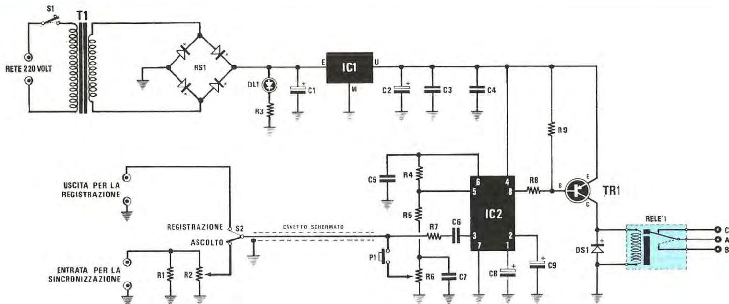
Fig. 1 Schema elettrico del sincronizzatore automatico per diaproiettori. Il deviatore S2 commutato in «registrazione» servirà per incidere il nastro, in posizione «ascolto» invece, permetterà l'avanzamento delle diapositive ascoltandone per ognuna di esse il relativo commento e sottofondo musicale.
