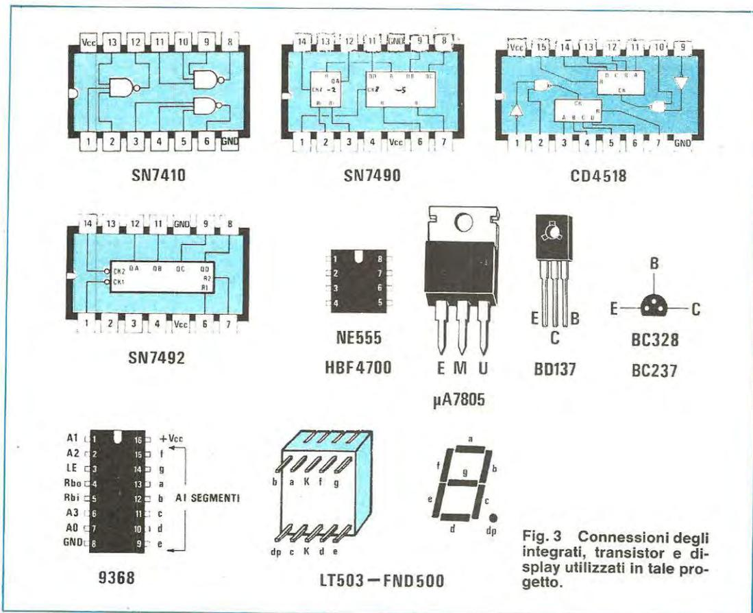
Fig. 3 Connessioni degli integrati, transistor e display utilizzati in tale progetto.
