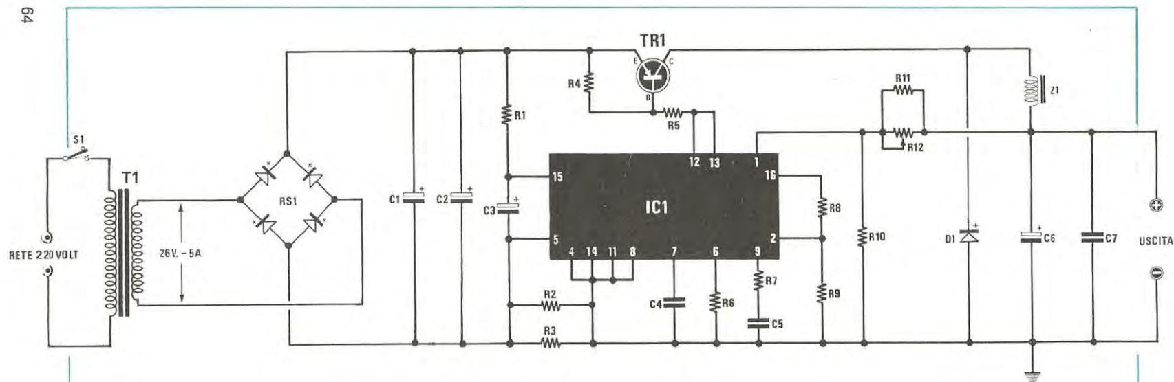
Fig. 4 Schema elettrico e connessioni del transistor MJ.2501 e dell'integrato SG.3524 equivalente all'LM.3524 utilizzato per il convertitore CC. presentato a pag. 10.
