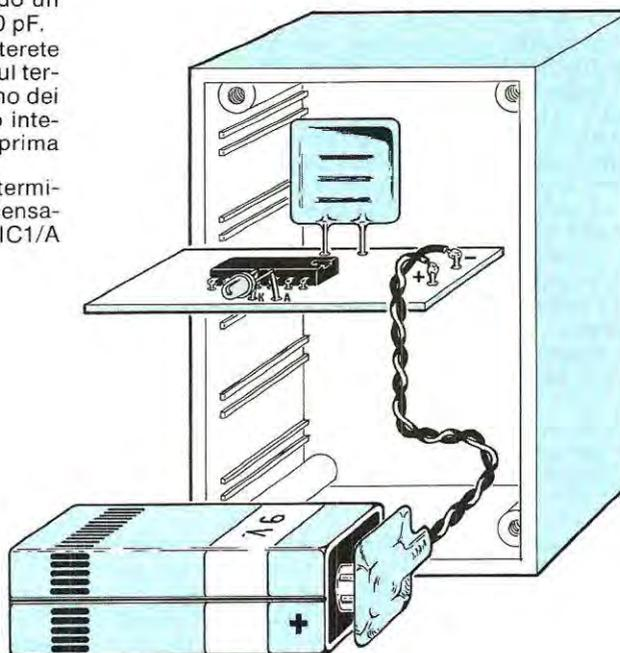
Fig. 6 Il circuito stampato come vedesi in questo disegno e nella foto di sinistra deve essere infilato verticalmente nelle due guide presenti all'interno del mobile. Di lato il piano di foratura del pannello di alluminio.
