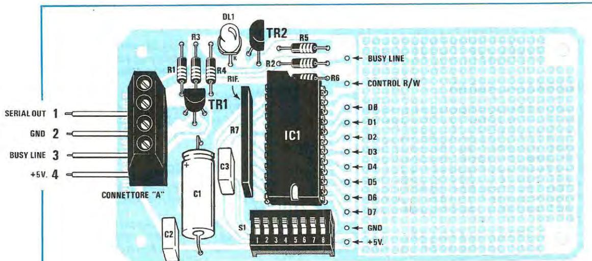
**Fig. 9** Schema pratico di montaggio della scheda universale che potrete completare con i più svariati circuiti sperimentali di vostra progettazione.
