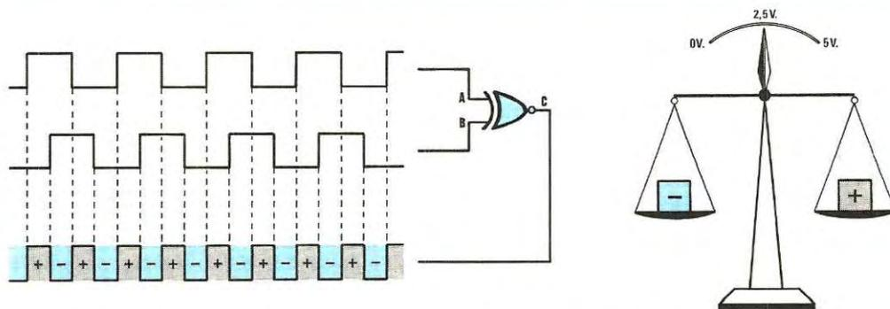
**Fig. 7** Quando la frequenza presente sull'ingresso A risulta sfasata di  $90^\circ$  gradi rispetto a quella applicata sull'ingresso B, in uscita del Nor avremo un'onda quadra in cui la larghezza della semionda positiva risulta perfettamente identica a quella della semionda negativa e quindi, risultano identici di due "pesi", la tensione presente sul condensatore del filtro passa-basso si stabilizzerà sul valore richiesto.
