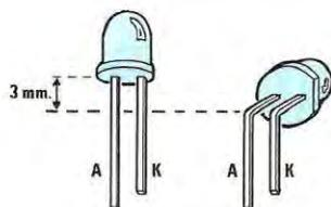
Fig. 5 Per far fuoriuscire il corpo del diodo led dal pannello del contenitore occorre ripiegare i suoi terminali ad "L" rivolgendolo, come vedesi in questo disegno, il terminale più corto (K) verso destra.
