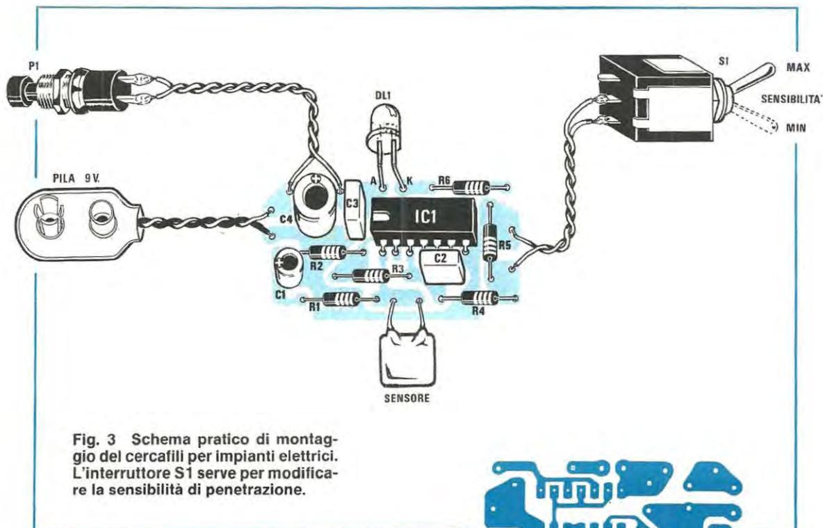
**Fig. 3** Schema pratico di montaggio del cercafili per impianti elettrici. L'interruttore S1 serve per modificare la sensibilità di penetrazione.
