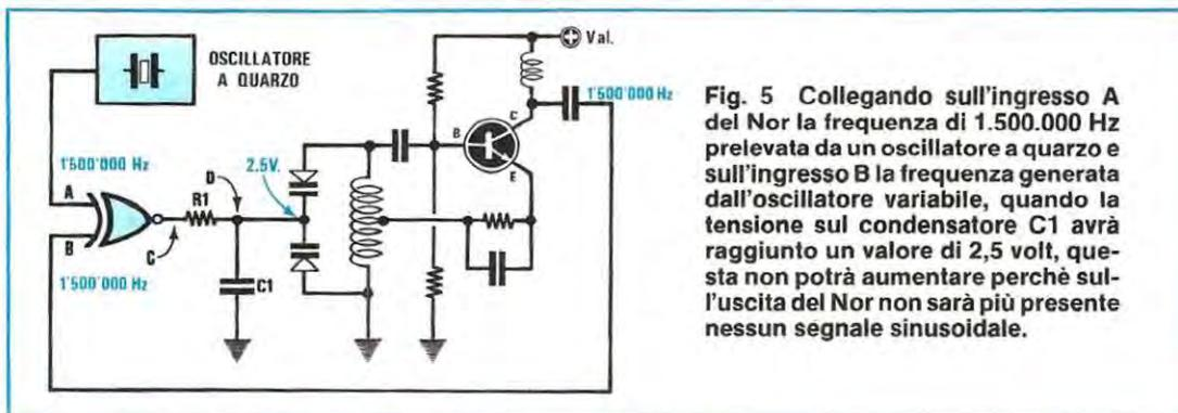
Fig. 5 Collegando sull'ingresso A del Nor la frequenza di 1.500.000 Hz prelevata da un oscillatore a quarzo e sull'ingresso B la frequenza generata dall'oscillatore variabile, quando la tensione sul condensatore C1 avrà raggiunto un valore di 2,5 volt, questa non potrà aumentare perché sull'uscita del Nor non sarà più presente nessun segnale sinusoidale.
