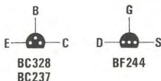
Tutti i componenti, compreso commutatore e potenziometri vengono montati su un unico circuito stampato siglato LX.609. Di lato le connessioni dei transistor e del fet utilizzati in tale montaggio viste da sotto.
