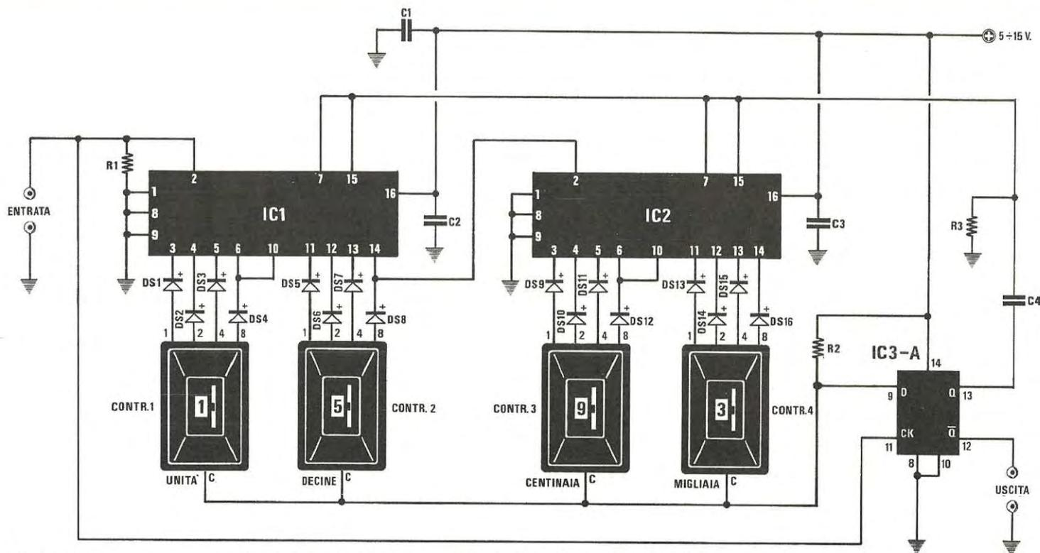
Fig. 35 Divisore programmabile a C/Mos che divide da 1 fino a 9.999 volte. Questo circuito lo potremo alimentare con una tensione minima di 5 volt e massima di 15 volt.
