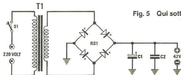
Fig. 5 Qui sotto lo schema elettrico dell'alimentatore.
