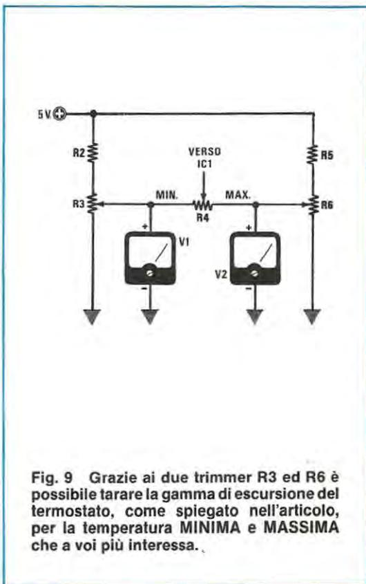
**Fig. 9** Grazie ai due trimmer R3 ed R6 è possibile tarare la gamma di escursione del termostato, come spiegato nell'articolo, per la temperatura MINIMA e MASSIMA che a voi più interessa.
