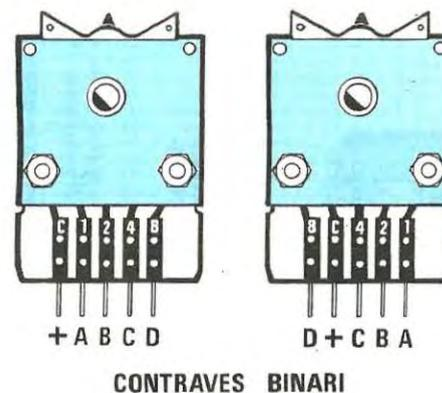
Fig. 28 Connessioni dei terminali di due diversi contatori binari. Note la differente disposizione del + e degli ingressi A-B-C-D.
