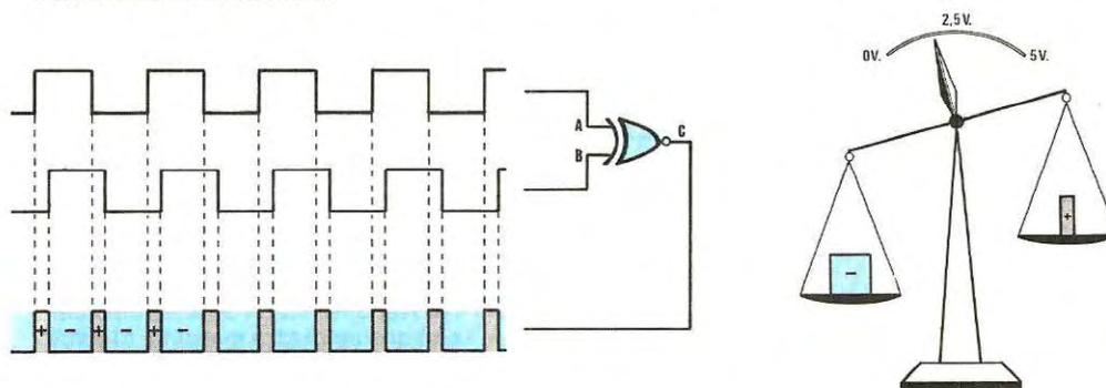
**Fig. 9** Se la frequenza del VCO da 1.500.000 Hz aumentasse anche di un solo hertz passando così a 1.500.001 Hz, otterremo un effetto opposto a quello di fig. 8, cioè sull'uscita del Nor ritroveremmo un'onda quadra in cui la semionda positiva risulta più STRETTA della semionda negativa. Risultando il "peso" negativo maggiore di quello positivo, la tensione sul condensatore diminuirà.
