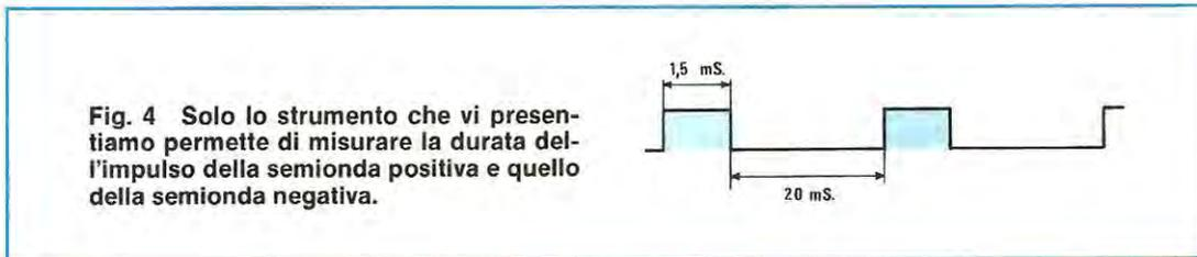
**Fig. 4** Solo lo strumento che vi presentiamo permette di misurare la durata dell'impulso della semionda positiva e quello della semionda negativa.
