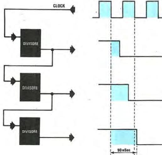
Fig. 30 Utilizzando dei divisori asincroni, poiché l'impulso della frequenza da dividere dal primo divisore passa al secondo divisore, il tempo di ritardo di propagazione viene sommato ad ogni passaggio, quindi, più stadi divisori aggiungiamo, minore risulterà la frequenza massima che potremo applicare sull'ingresso, perchè il contatore non perda dei clock. Per questo motivo molti notano una differenza fra la frequenza generata e la frequenza impostata sui commutatori binari.
