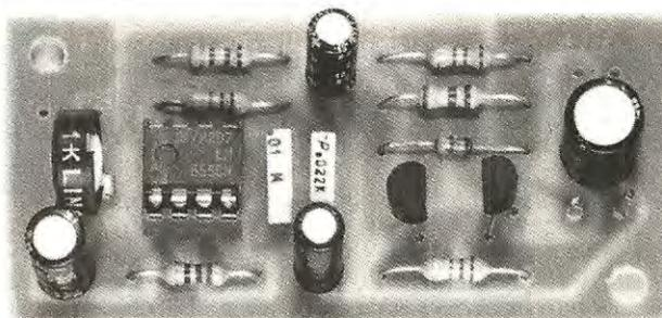
Qui sopra la foto del decodificatore necessario per generare la nota di BF a 1.300 Hz da applicare sul microfono del ricetrasmittitore.
