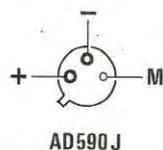
Fig. 1 La sonda AD.590 pur avendo le stesse identiche dimensioni di un normale transistor metallico tipo BC.107, nell'interno del suo involucro presenta ben 11 transistor, 1 fet, 1 condensatore e 6 resistenze (due sono NTC). In alto, le connessioni viste da sotto dei terminali, e qui di lato lo schema elettrico dell'AD.590.
