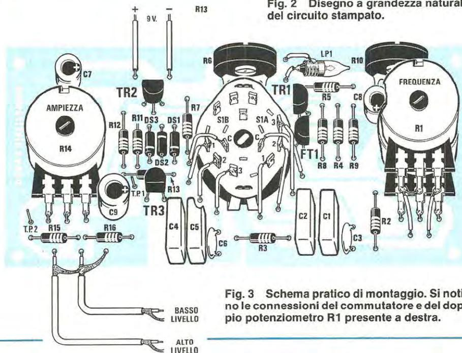
Fig. 3 Schema pratico di montaggio. Si notino le connessioni del commutatore e del doppio potenziometro R1 presente a destra.
