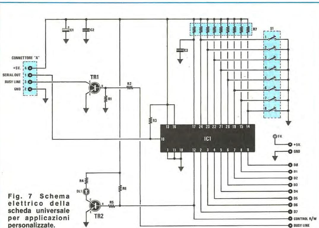
Fig. 7 Schema elettrico della scheda universale per applicazioni personalizzate.
