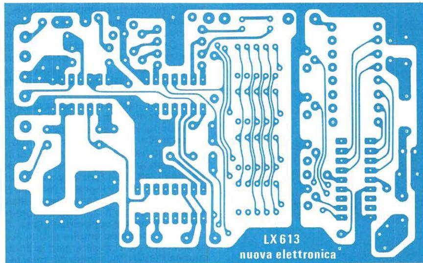
Fig. 6 Disegno a grandezza naturale del circuito stampato. Tale circuito, essendo un doppia faccia a fori metallizzati, non potrà essere autoinciso.
