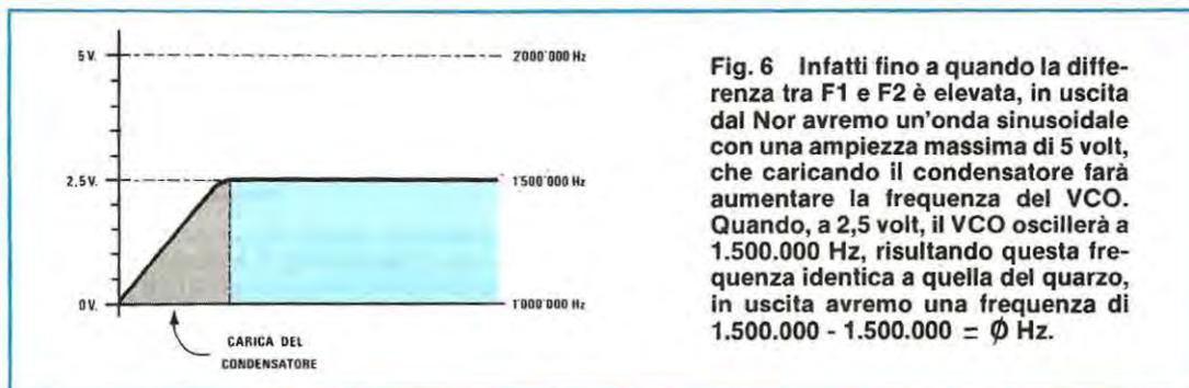
Fig. 6 Infatti fino a quando la differenza tra F1 e F2 è elevata, in uscita dal Nor avremo un'onda sinusoidale con una ampiezza massima di 5 volt, che caricando il condensatore farà aumentare la frequenza del VCO. Quando, a 2,5 volt, il VCO oscillerà a 1.500.000 Hz, risultando questa frequenza identica a quella del quarzo, in uscita avremo una frequenza di  $1.500.000 - 1.500.000 = \emptyset$  Hz.
