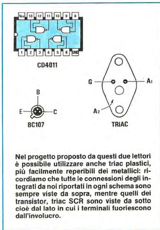
**Nel progetto proposto da questi due lettori è possibile utilizzare anche triac plastici, più facilmente reperibili dei metallici: ricordiamo che tutte le connessioni degli integrati da noi riportati in ogni schema sono sempre viste da sopra, mentre quelli dei transistor, triac SCR sono viste da sotto cioè dal lato in cui i terminali fuoriescono dall'involucro.**
