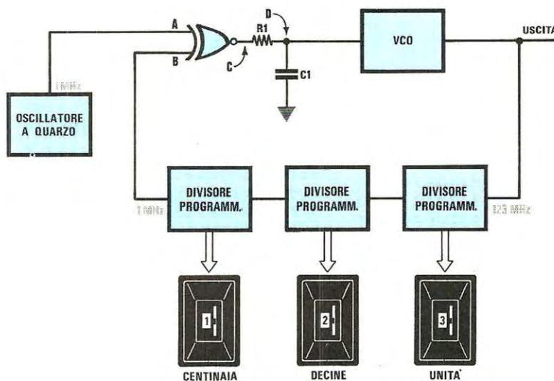
Fig. 15 Se gli esempi riportati in fig. 11-12-13-14- possono risultare validi per realizzare dei trasmettitori su determinate frequenze fisse, non risultano più vantaggiosi per realizzare ricetrasmittitori "multicanali". Per ottenere sempre con un solo quarzo molteplici frequenze, conviene utilizzare dei divisori programmabili, collegati a dei commutatori binari o dip-switch.
