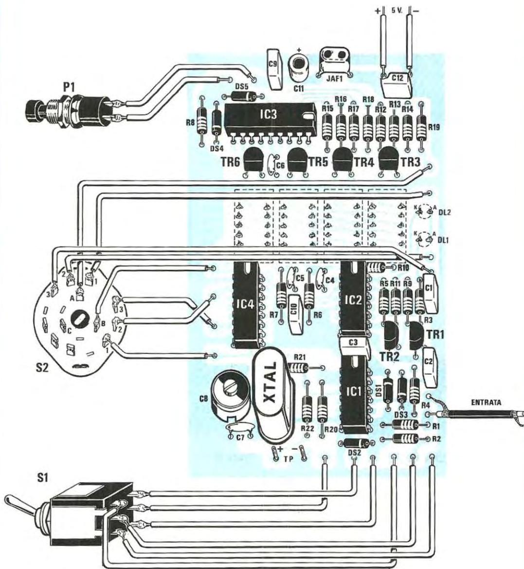
**Fig. 8** Schema pratico di montaggio del periodimetro. Eseguendo questo montaggio dovrete fare attenzione ai collegamenti esterni, cioè quelli che fanno capo al commutatore rotativo S2 ed al doppio deviatore S1. Invertendo uno di questi fili il circuito non riuscirà a funzionare.
