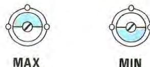
Fig. 5 Nei compensatori ceramici, la massima capacità si ha quando la parte argentea (da noi colorata in azzurro) è rivolta verso il terminale centrale.
