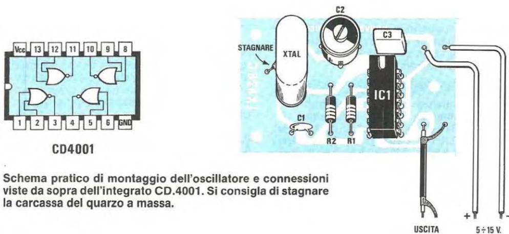
Schema pratico di montaggio dell'oscillatore e connessioni viste da sopra dell'integrato CD.4001. Si consiglia di stagnare la carcassa del quarzo a massa.
