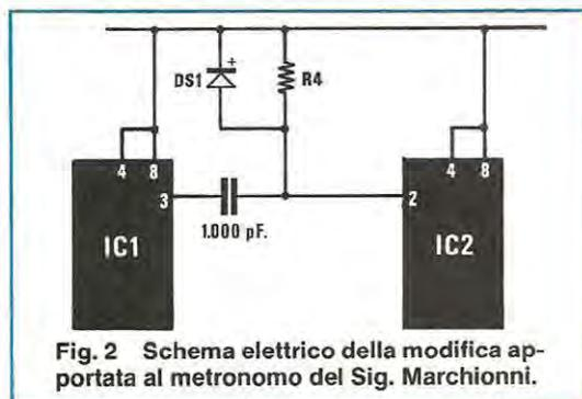
**Fig. 2** Schema elettrico della modifica apportata al metronomo del Sig. Marchionni.
