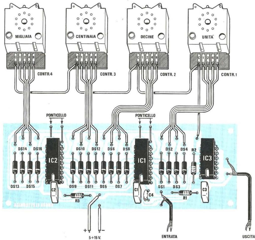
Fig. 36 Schema pratico del divisore a C/Mos. Si noti i due ponticelli posti sopra a IC2 e IC1 e a sinistra il disegno a grandezza naturale del circuito stampato.
