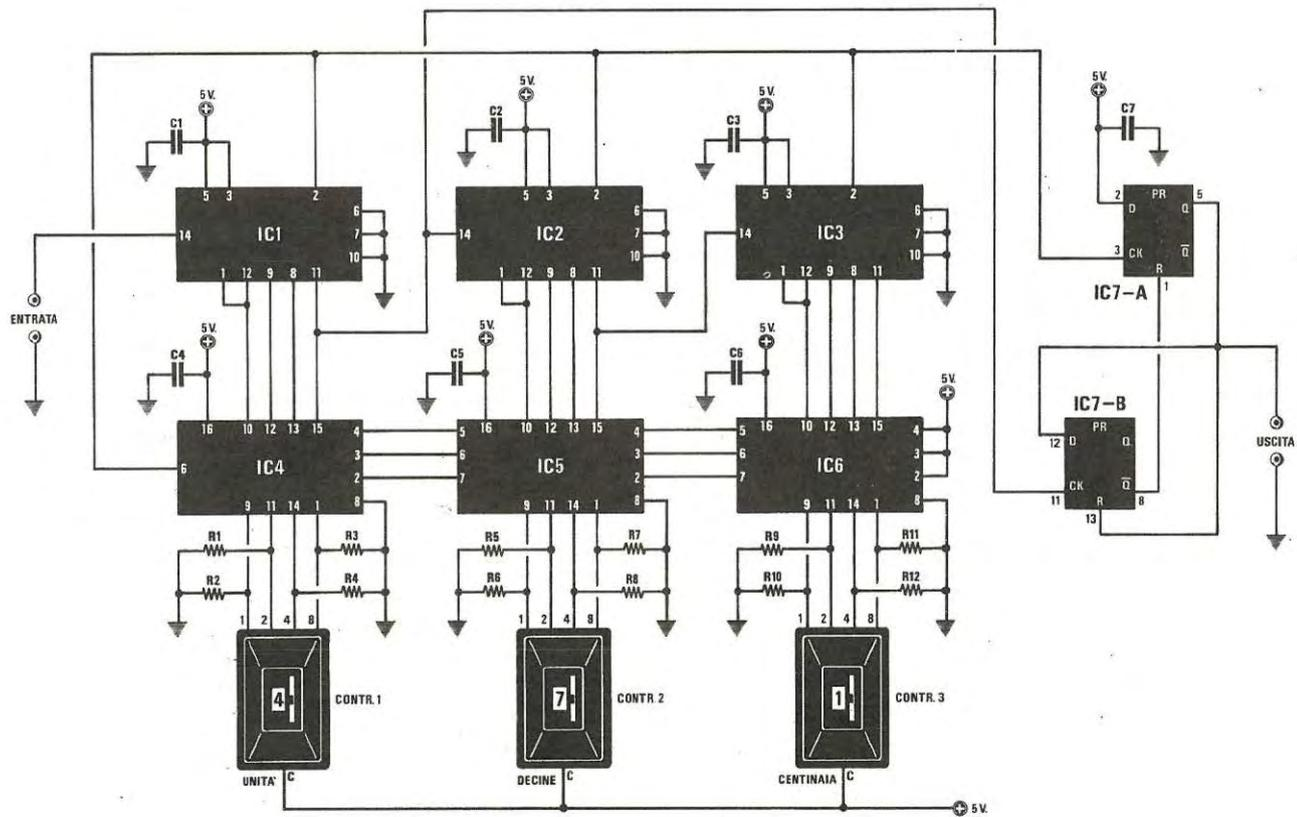
Fig. 26 Schema elettrico di un divisore da 1 a 999. Avendo applicato sulle uscite degli SN.7490 dei comparatori SN.7485 o SN.74LS85 in sostituzione dei diodi (vedi fig. 23) il segnale risulta più pulito. Anche questo circuito richiede una tensione di alimentazione stabilizzata a 5 volt.
