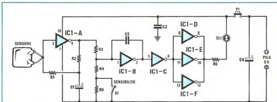
Fig. 1 Schema elettrico
