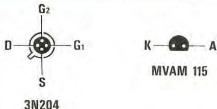
Fig. 4 Connessioni viste da sotto del mosfet e del diodo varicap utilizzati in tale progetto. Vedere in fig. 2 da quale lato è disposta la parte piana di tali diodi.
