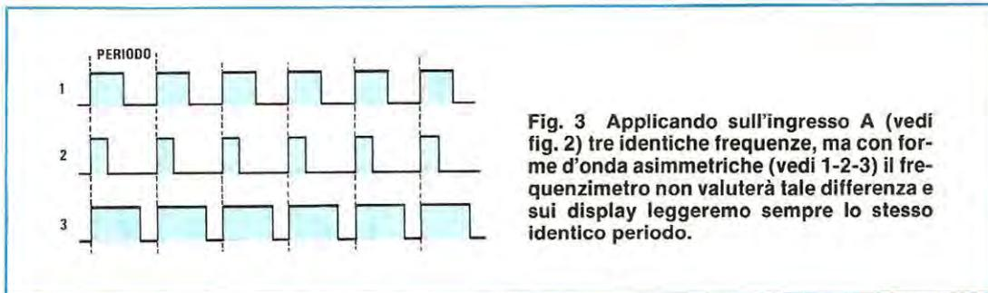
**Fig. 3** Applicando sull'ingresso A (vedi fig. 2) tre identiche frequenze, ma con forme d'onda asimmetriche (vedi 1-2-3) il frequenzimetro non valuterà tale differenza e sui display leggeremo sempre lo stesso identico periodo.
