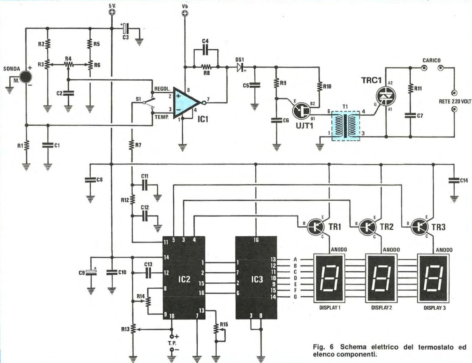
Fig. 6 Schema elettrico del termostato ed elenco componenti.
