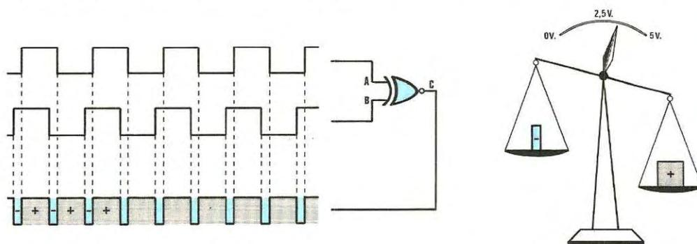
**Fig. 8** Se la frequenza del VCO, applicata sull'ingresso B, tendesse a slittare e passare così da 1.500.000 Hz a 1.499.999 Hz, la differenza di fase sui due ingressi si modificherebbe e in uscita del Nor ritroveremmo un'onda quadra in cui la semionda positiva risulta più LARGA della semionda negativa. Risultando il "peso" positivo maggiore del negativo, la tensione sul condensatore aumenterà.
