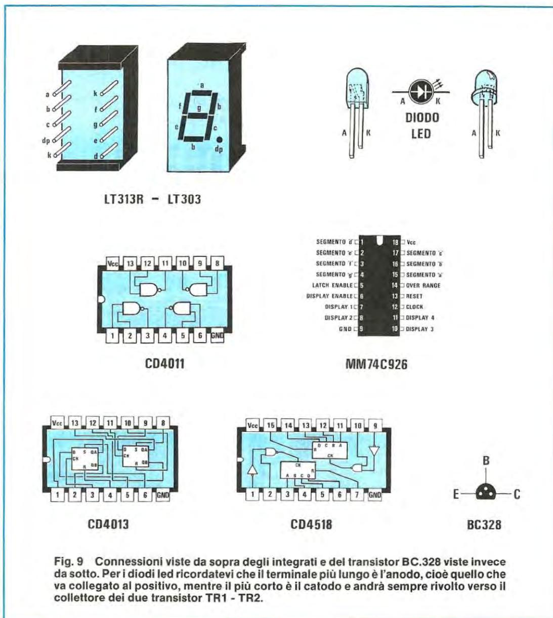
**Fig. 9** Connessioni viste da sopra degli integrati e del transistor BC.328 viste invece da sotto. Per i diodi led ricordatevi che il terminale più lungo è l'anodo, cioè quello che va collegato al positivo, mentre il più corto è il catodo e andrà sempre rivolto verso il collettore dei due transistor TR1 - TR2.
