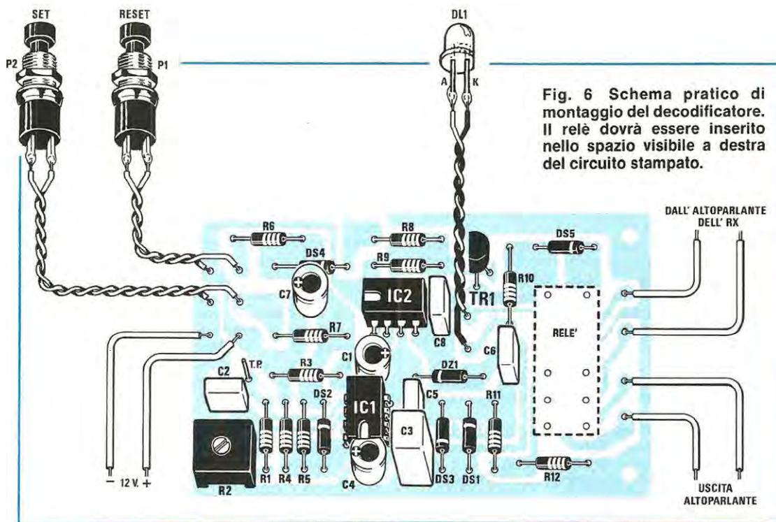
Fig. 6 Schema pratico di montaggio del decodificatore. Il relè dovrà essere inserito nello spazio visibile a destra del circuito stampato.
