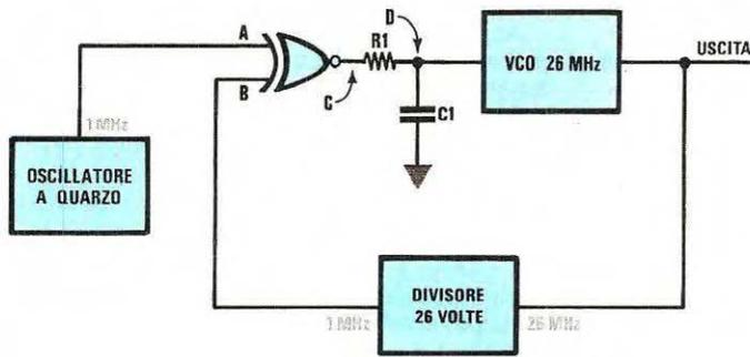
Fig. 11 Così, con un quarzo da 1 MHz e dividendo la frequenza del VCO di 26 volte, sugli ingressi A-B avremo sempre 1 MHz anche se l'oscillatore genera una frequenza di 26 MHz.
