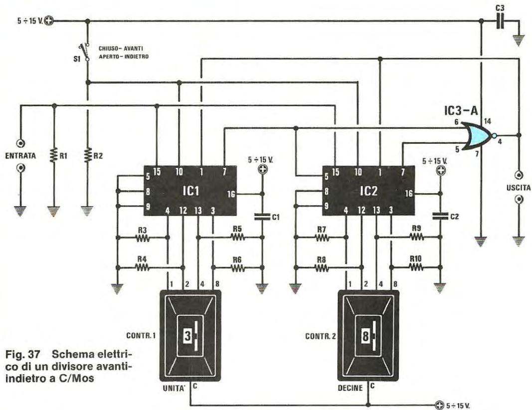
Fig. 37 Schema elettrico di un divisore avanti-indietro a C/Mos
