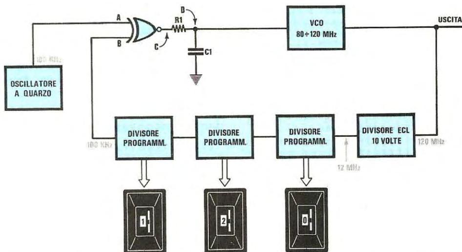
Fig. 16 Se come primo divisore  $\times 10$  abbiamo utilizzato un integrato ECL, (non sono programmabili) per poter ottenere tanti canali quanti potevamo ottenerne con il circuito di fig. 15, occorre ridurre la frequenza del quarzo di riferimento di 10 volte, cioè utilizzare un quarzo da 0,1 MHz, anziché uno da 1 MHz.
