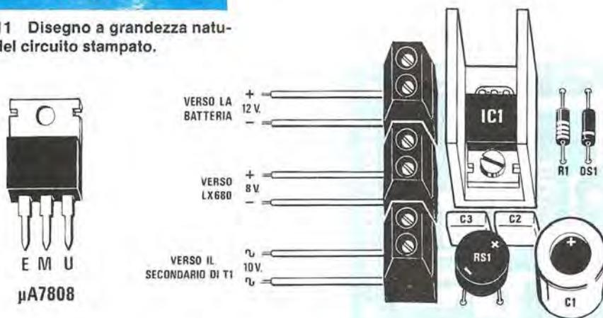
Fig. 12 Connessioni dell'integrato stabilizzatore uA.7808 e schema pratico di montaggio dell'alimentatore stabilizzato che racchiuderemo a parte, in un piccolo contenitore. Sulla morsettiere posta in basso, collegheremo il secondario di un trasformatore in grado di erogare 10 volt 1 amper (n. 25).
