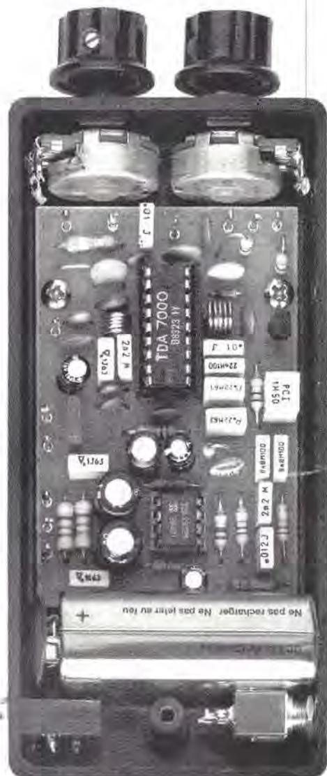
In questa foto possiamo vedere il ricevitore FM descritto nell'articolo, già completato ed inserito entro al mobile plastico da noi fornito.
