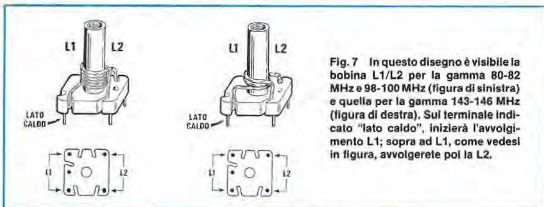
Fig. 7 In questo disegno è visibile la bobina L1/L2 per la gamma 80-82 MHz e 98-100 MHz (figura di sinistra) e quella per la gamma 143-146 MHz (figura di destra). Sul terminale indicato "lato caldo", inizierà l'avvolgimento L1; sopra ad L1, come vedesi in figura, avvolgerete poi la L2.
