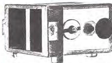
Dal lato opposto della cavità, troverete il terminale TX (trasmittente) che dovrete collegare, come visibile nello schema elettrico di fig. 4, ad una normale tensione stabilizzata di 8 volt.
