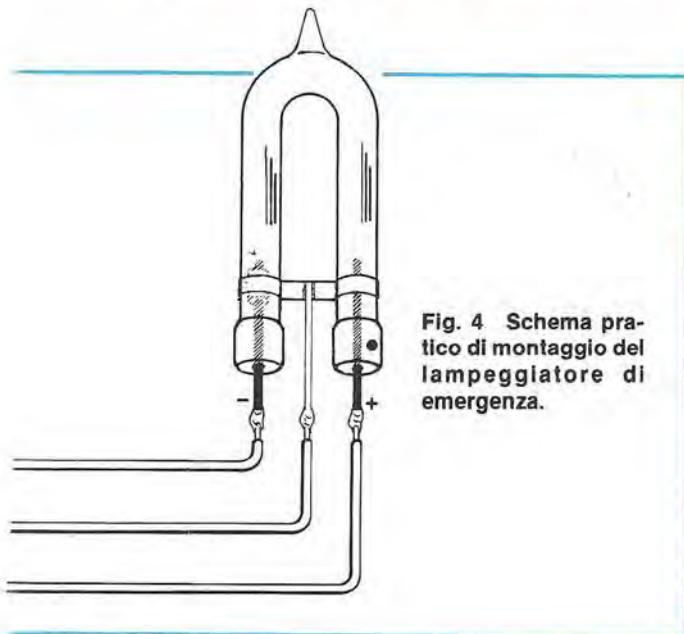
**Fig. 4** Schema pratico di montaggio del lampeggiatore di emergenza.
