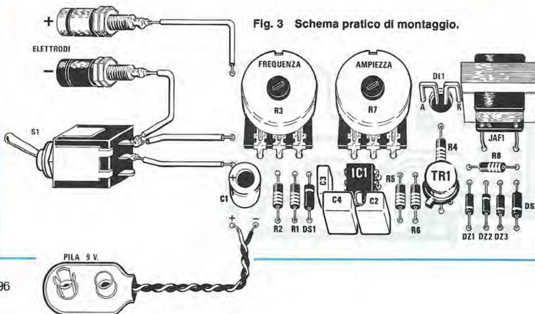
Fig. 3 Schema pratico di montaggio.
