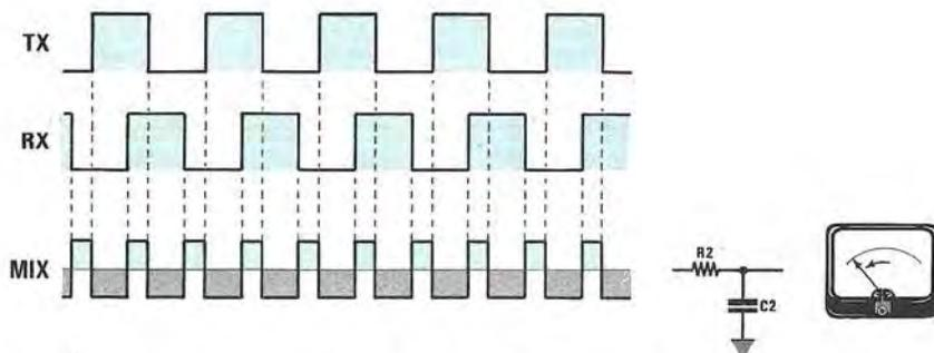
**Fig. 3** Come potete notare in fig. 2, risultando la semionda positiva del segnale MIX più larga della semionda negativa, il voltmetro rileverà più tensione positiva, in questa figura invece, risultando la semionda positiva più stretta di quella negativa, il voltmetro rileverà una minor tensione rispetto alla condizione precedente.
