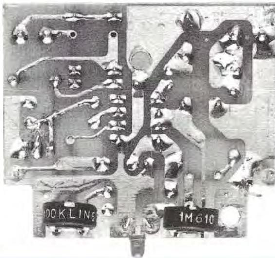
Come visibile in fig. 7, sul lato opposto di questo stesso circuito, inserite i due trimmer R14 e R21 ed il diodo led, ripiegando a L i suoi due terminali, in modo che il corpo possa poi leggermente fuoriuscire dal ritaglio di plastica "radom".
