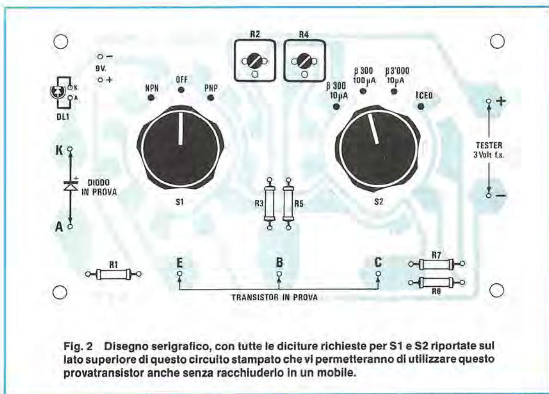
**Fig. 2** Disegno serigrafico, con tutte le diciture richieste per S1 e S2 riportate sul lato superiore di questo circuito stampato che vi permetteranno di utilizzare questo provatransistor anche senza racchiuderlo in un mobile.
