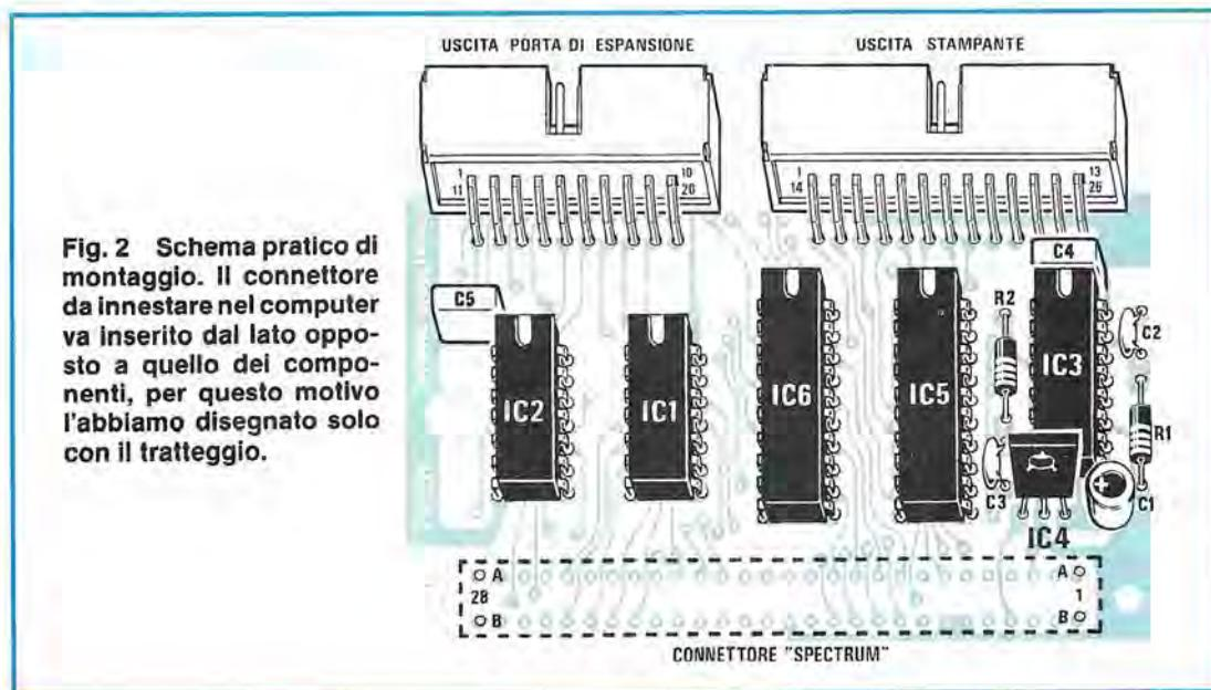
**Fig. 2** Schema pratico di montaggio. Il connettore da innestare nel computer va inserito dal lato opposto a quello dei componenti, per questo motivo l'abbiamo disegnato solo con il tratterggio.
