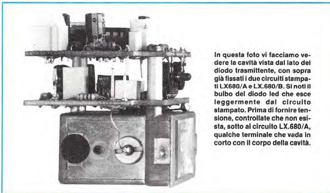
In questa foto vi facciamo vedere la cavità vista dal lato del diodo trasmittente, con sopra già fissati i due circuiti stampati LX.680/A e LX.680/B. Si noti il bulbo del diodo led che esce leggermente dal circuito stampato. Prima di fornire tensione, controllate che non esista, sotto al circuito LX.680/A, qualche terminale che vada in corto con il corpo della cavità.
