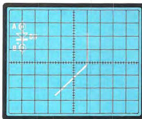
**Fig. 37** Invertendo il diodo in modo che il catodo risulti rivolto verso l'alto, la L apparirà totalmente rovesciata.
