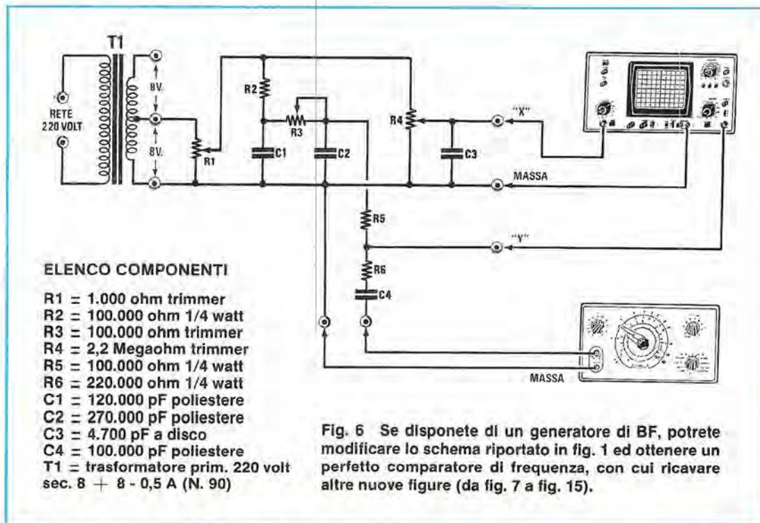
Fig. 6 Se disponete di un generatore di BF, potrete modificare lo schema riportato in fig. 1 ed ottenere un perfetto comparatore di frequenza, con cui ricavare altre nuove figure (da fig. 7 a fig. 15).
