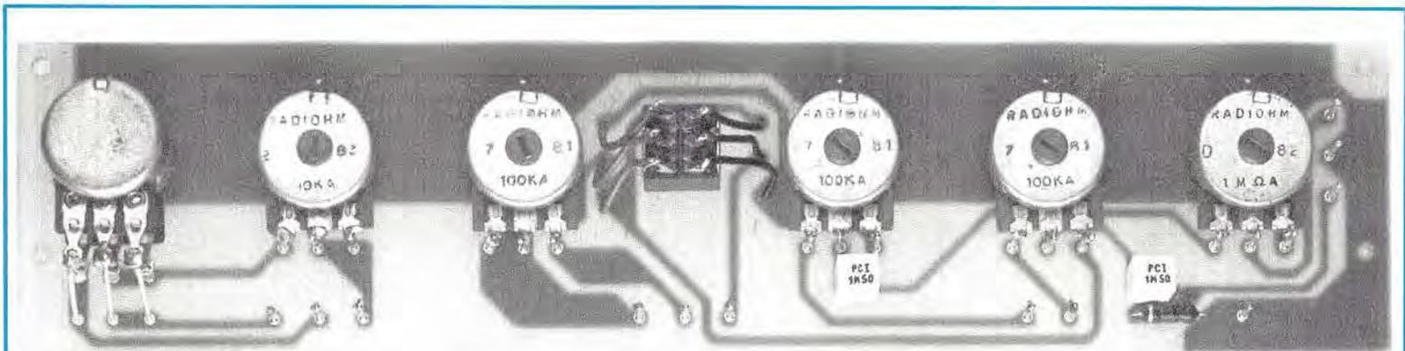
Qui sopra la foto del circuito LX.666-A con i potenziometri e il doppio deviatore S1 già montati e con tutti i terminali collegati alle relative piste. Sotto, lo stesso circuito stampato visto dal lato opposto. Facciamo presente che per questo progetto è disponibile un mobile metallico verniciato color beige con mascherina frontale in alluminio ossidato, già forato e completo di serigrafia.
