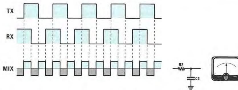
**Fig. 1** Sul diodo ricevente Schottky, oltre al segnale generato dal diodo trasmettente (vedi onde indicate TX) giunge, leggermente in ritardo, anche il segnale riflesso dalle pareti (vedi onde indicate RX). Dal battimento di questi due segnali, si ricava una terza frequenza (MIX) che sfrutteremo per ricavare una tensione continua.
