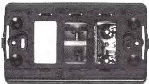
**Il vano centrale di tale pannello, lo utilizzerete per la cavità, quello di destra per poter accedere ai due trimmer R14 e R21 della sensibilità e del timer mentre il vano posto a sinistra, per inserire un normale interruttore utile per accendere la luce della stanza.**
