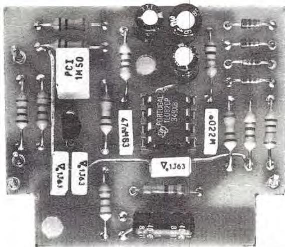
Per facilitarvi il montaggio, riportiamo qui di lato la foto ingrandita del circuito stampato LX.680/A vista dal lato componenti. Si noti il condensatore C4 collocato in posizione orizzontale e i due fori sul circuito stampato che utilizzerete per fissare direttamente questo circuito sul corpo della cavità.
