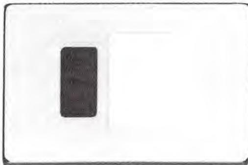
**Sotto al coperchio frontale che coprirà il pannello ad incasso, dovrete inserire quel sottile ritaglio di plastica bianca che vi forniremo nel kit. Non cercate di sostituire questa plastica con altro materiale perchè, quella da noi fornita, presenta la caratteristica di non attenuare il segnale dei 10 GHz.**
