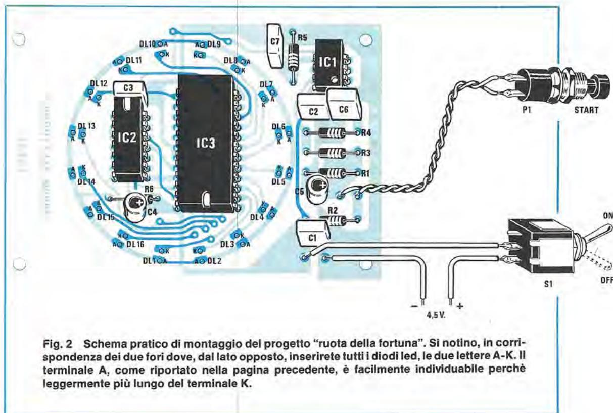
**Fig. 2** Schema pratico di montaggio del progetto "ruota della fortuna". Si notino, in corrispondenza dei due fori dove, dal lato opposto, inserite tutti i diodi led, le due lettere A-K. Il terminale A, come riportato nella pagina precedente, è facilmente individuabile perchè leggermente più lungo del terminale K.
