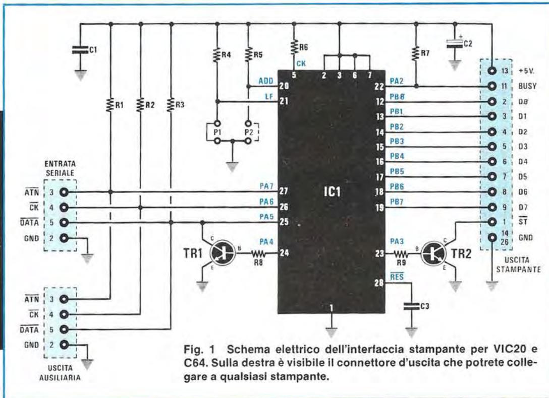
Fig. 1 Schema elettrico dell'interfaccia stampante per VIC20 e C64. Sulla destra è visibile il connettore d'uscita che potrete collegare a qualsiasi stampante.
