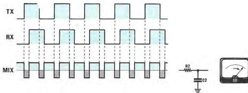
**Fig. 2** Se nella stanza non esistono oggetti in movimento, lo sfasamento tra i due segnali TX-RX rimarrà costante e, in tali condizioni, la lancetta dell'ipotetico voltmetro, da noi inserito, rimarrà immobile (vedi fig. 1). Un qualsiasi oggetto in movimento, modificando questo sfasamento, farà variare la forma delle semionde positive e negative.
