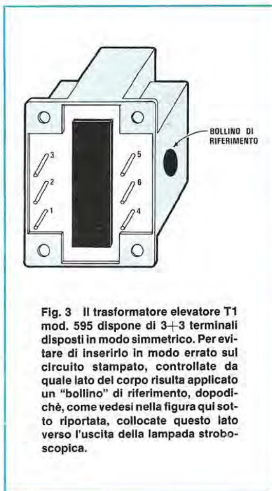
**Fig. 3** Il trasformatore elevatore T1 mod. 595 dispone di 3+3 terminali disposti in modo simmetrico. Per evitare di inserirlo in modo errato sul circuito stampato, controllate da quale lato del corpo risulta applicato un "bollino" di riferimento, dopodichè, come vedesi nella figura qui sotto riportata, collocate questo lato verso l'uscita della lampada stroboscopica.
