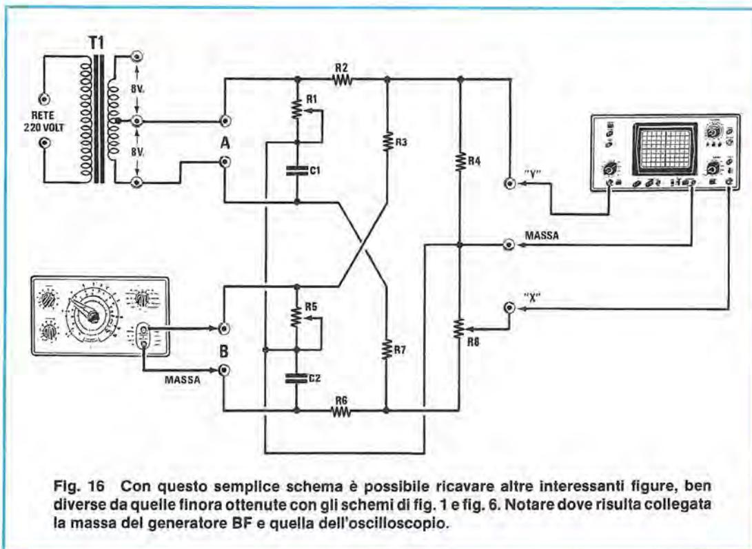
**Fig. 16** Con questo semplice schema è possibile ricavare altre interessanti figure, ben diverse da quelle finora ottenute con gli schemi di fig. 1 e fig. 6. Notare dove risulta collegata la massa del generatore BF e quella dell'oscilloscopio.
