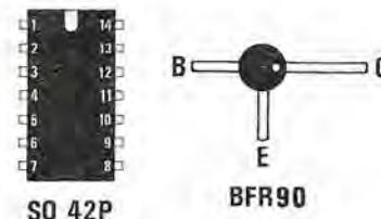
Fig. 5 Connessioni del SO.42P e del transistor BFR.90.
