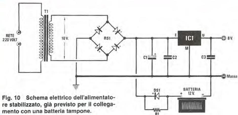
Fig. 10 Schema elettrico dell'alimentatore stabilizzato, già previsto per il collegamento con una batteria tampone.
