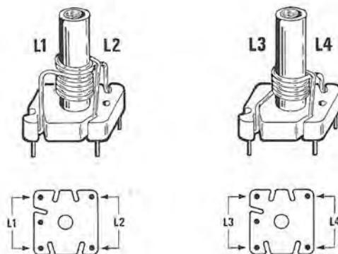
Agendo sul nucleo di cui la bobina è provvista, questa la potremo facilmente sintonizzare sulla frequenza utilizzata in trasmissione, cioè su 80-81-82 MHz.
