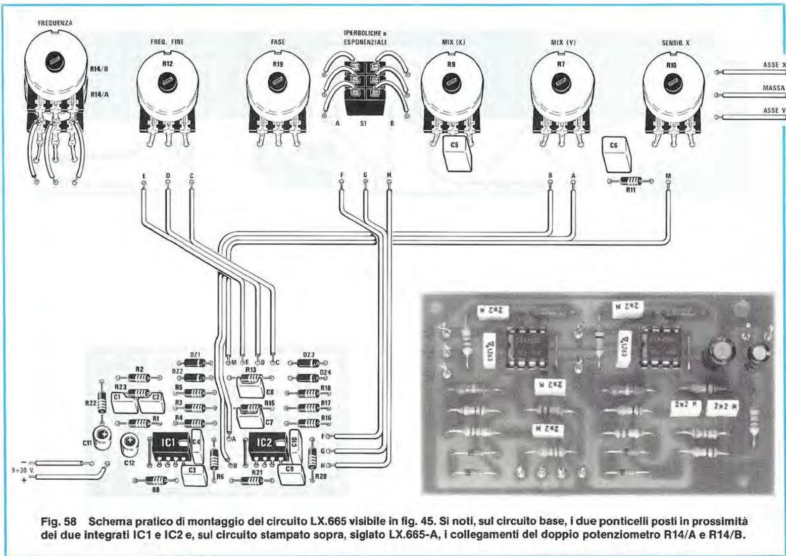
Fig. 58 Schema pratico di montaggio del circuito LX.665 visibile in fig. 45. Si noti, sul circuito base, i due ponticelli posti in prossimità dei due integrati IC1 e IC2 e, sul circuito stampato sopra, siglato LX.665-A, i collegamenti del doppio potenziometro R14/A e R14/B.
