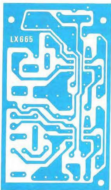
**Fig. 55** Disegno del circuito stampato LX.665 con il quale, assieme al circuito stampato LX.665/A visibile sul lato destro, potrete realizzare il progetto per ottenere figure esponenziali e iperboliche, di cui abbiamo riportato alcuni esempi nelle pagine precedenti.
