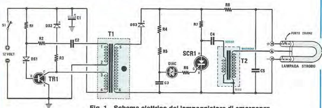
Fig. 1 Schema elettrico del lampeggiatore di emergenza.
