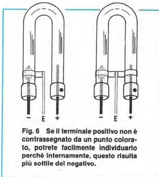
**Fig. 6** Se il terminale positivo non è contrassegnato da un punto colorato, potrete facilmente individuarlo perchè internamente, questo risulta più sottile del negativo.
