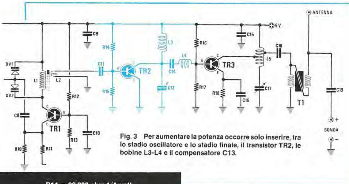
Fig. 3 Per aumentare la potenza occorre solo inserire, tra lo stadio oscillatore e lo stadio finale, il transistor TR2, le bobine L3-L4 e il compensatore C13.
