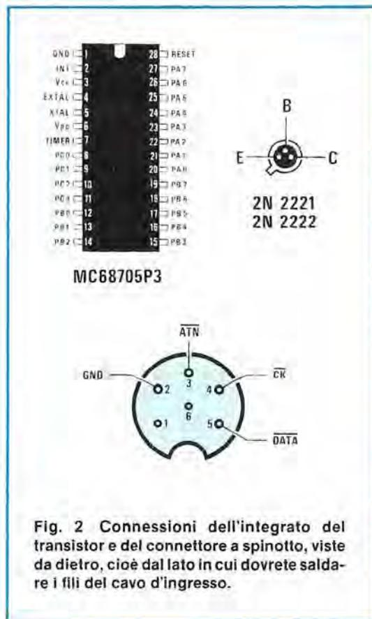
**Fig. 2** Connessioni dell'integrato del transistor e del connettore a spinotto, viste da dietro, cioè dal lato in cui dovrete saldare i fili del cavo d'ingresso.
