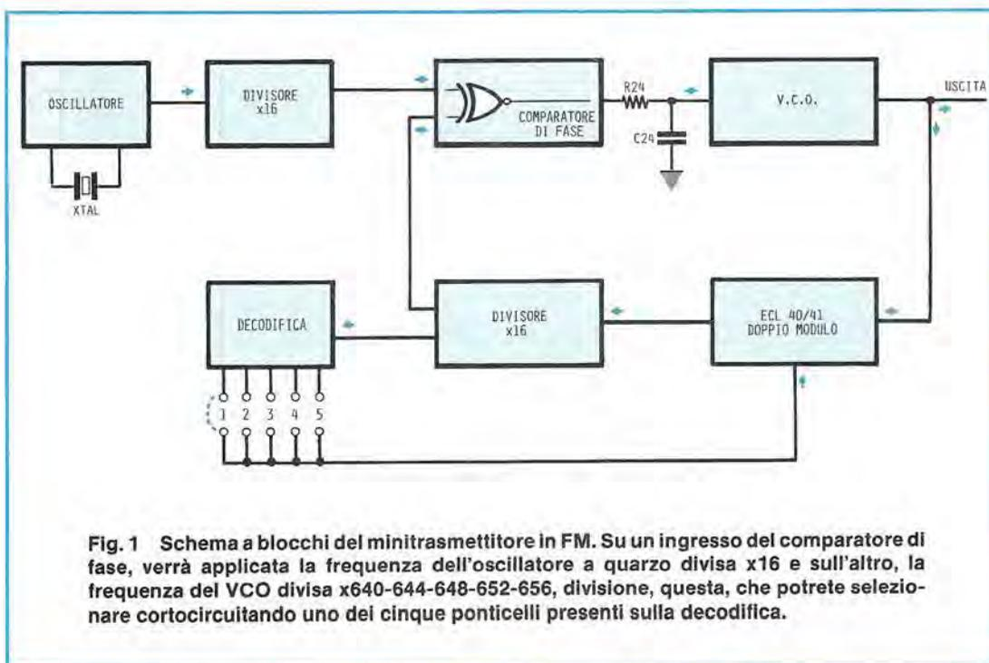
**Fig. 1** Schema a blocchi del minitrasmittitore in FM. Su un ingresso del comparatore di fase, verrà applicata la frequenza dell'oscillatore a quarzo divisa x16 e sull'altro, la frequenza del VCO divisa x640-644-648-652-656, divisione, questa, che potrete selezionare cortocircuitando uno dei cinque ponticelli presenti sulla decodifica.
