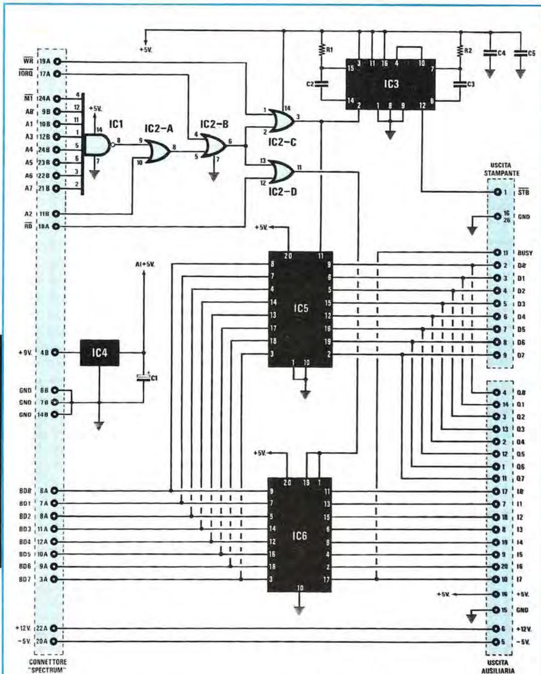
**Fig. 1** Schema elettrico dell'interfaccia stampante, idonea per computer Spectrum della Sinclair. Dei due connettori posti sulla destra, dovrete utilizzare, per la stampante, solo quello posto in alto, il connettore posto in basso servirà come uscita ausiliaria per altre interfacce.
