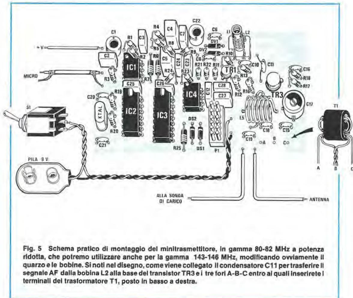
**Fig. 5** Schema pratico di montaggio del minitrasmittitore, in gamma 80-82 MHz a potenza ridotta, che potremo utilizzare anche per la gamma 143-146 MHz, modificando ovviamente il quarzo e le bobine. Si noti nel disegno, come viene collegato il condensatore C11 per trasferire il segnale AF dalla bobina L2 alla base del transistor TR3 e i tre fori A-B-C entro ai quali inserirete i terminali del trasformatore T1, posto in basso a destra.
