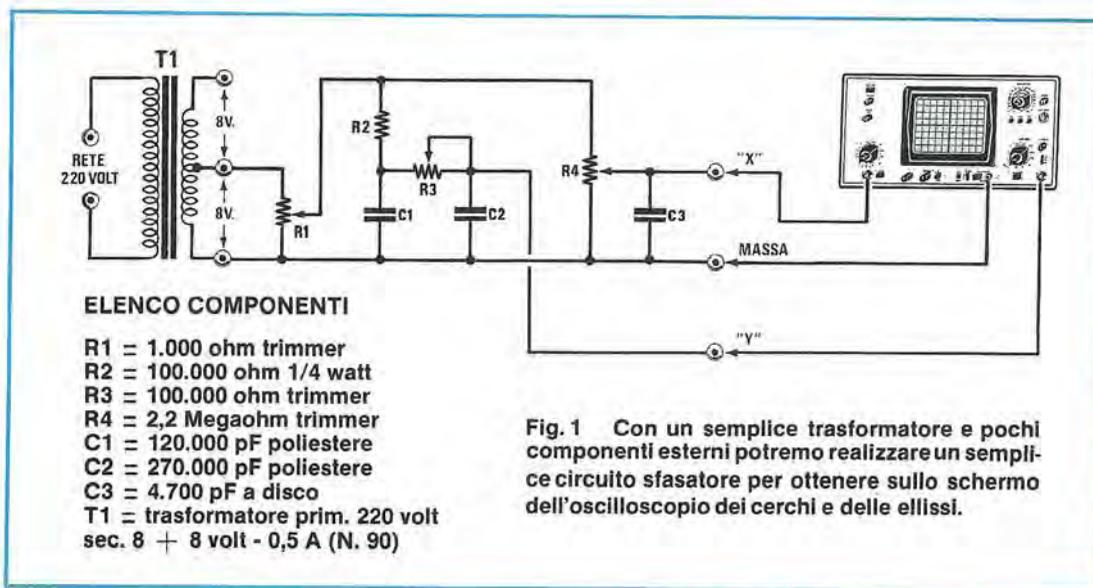
Fig. 1 Con un semplice trasformatore e pochi componenti esterni potremo realizzare un semplice circuito sfasatore per ottenere sullo schermo dell'oscilloscopio dei cerchi e delle ellissi.
