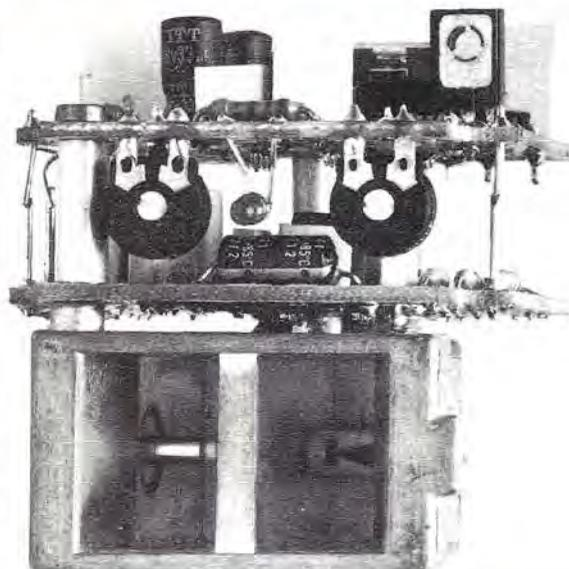
Sulla destra, la foto della cavità con sopra già fissati i due circuiti stampati. Internamente, nei due vani della cavità, si intravede a destra il diodo ricevente Schottky e a sinistra il diodo trasmittente Gunn.
