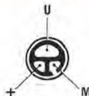
**Fig. 9** Se nello zoccolo del vostro microfono preamplificato è presente, al centro, una pista di dimensioni maggiori (vedi U), questa è il terminale di uscita del segnale di BF. In questo caso, sulla pista di destra avremo la "massa" sempre collegata elettricamente al metallo del microfono e sulla sinistra il terminale + di alimentazione.
