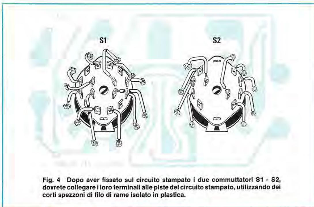
**Fig. 4** Dopo aver fissato sul circuito stampato i due commutatori S1 - S2, dovrete collegare i loro terminali alle piste del circuito stampato, utilizzando dei corti spezzoni di filo di rame isolato in plastica.
