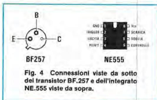
**Fig. 4 Connessioni viste da sotto del transistor BF.257 e dell'integrato NE.555 viste da sopra.**
