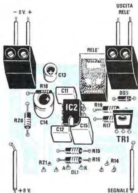
Fig. 6 Schema pratico di montaggio del secondo stampato siglato LX.680/B. Nella morsettiere posta a sinistra, invieremo la tensione stabilizzata degli 8 volt, su quella di destra usciranno i due fili che fanno capo ai contatti del relè.
