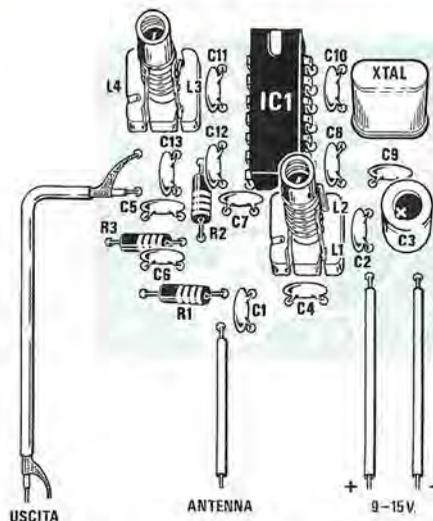
Fig. 3 Schema pratico di montaggio del convertitore.
