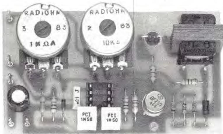
Foto di uno dei prototipi da noi montati. Si noti, sulla destra, l'impedenza da 1 Henry e, vicino a questa, il foro per far fuoriuscire dal lato opposto il diodo led DL1.
