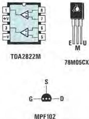
**Fig. 4** Connessioni dell'integrato stabilizzatore 78M05.CX e del fet MPF102 viste da sotto mentre, per l'integrato TDA2822, le connessioni sono viste da sopra. Come spiegato nell'articolo questo doppio finale di BF è in grado di pilotare anche due piccoli altoparlanti da 4 e 8 ohm.
