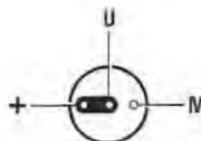
Se posteriormente trovate tre terminali in linea, quello centrale isolato dalla massa sarà il terminale d'uscita del segnale di BF, l'altro isolato il terminale + di alimentazione ed il terzo, sempre collegato al metallo del microfono, sarà quello di massa.
