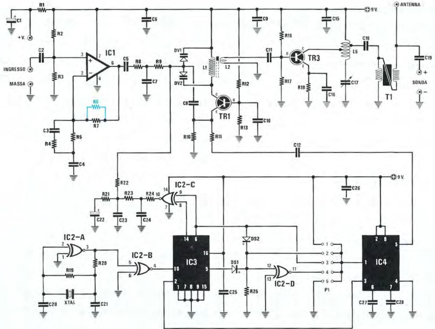
Fig. 2 Schema elettrico del minitrasmittitore a minor potenza. I valori dei componenti non riportati, servono solo per lo schema di fig. 3.
