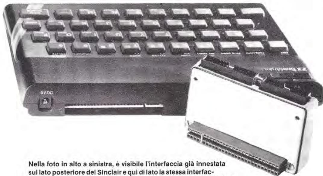
Nella foto in alto a sinistra, è visibile l'interfaccia già innestata sul lato posteriore del Sinclair e qui di lato la stessa interfaccia, sulla quale potete vedere la disposizione del connettore femmina da innestare nel computer.
