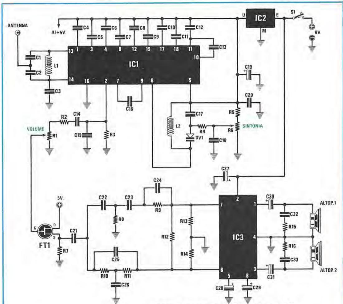
Schema elettrico del miniricevitore per FM.
