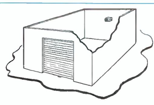
**Fig. 14** Per negozi o garage la soluzione più valida è quella di rivolgere il sensore verso la saracinesca d'ingresso. Ovviamente, se qualcuno tentasse di entrare attraverso un "buco", il sensore lo rilevarebbe immediatamente.
