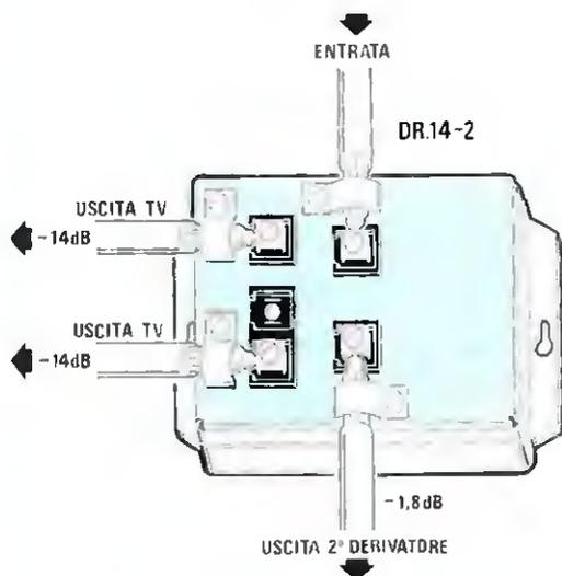
Fig.121 In un Derivatore modello DR.14-2 sono presenti una presa d'ingresso, due di uscita per la TV ed una di passaggio. L'attenuazione di prelievo TV rimarrà sempre fissa sui 14 dB, mentre aumenta l'attenuazione di passaggio che, rispetto alla prima di 0,7 dB, in questo modello passa a 1,8 dB.
