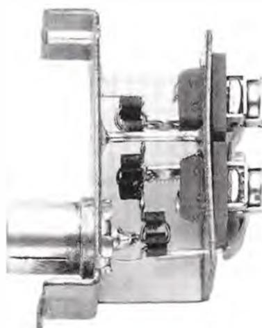
**Fig.135** In questa foto, l'interno di una Presa Passante tipo PP.4.2. Poiché questa presa dispone di una attenuazione di passaggio di 4,2 dB, la sua uscita passante si potrà collegare direttamente ad una presa finale tipo PF.0.
