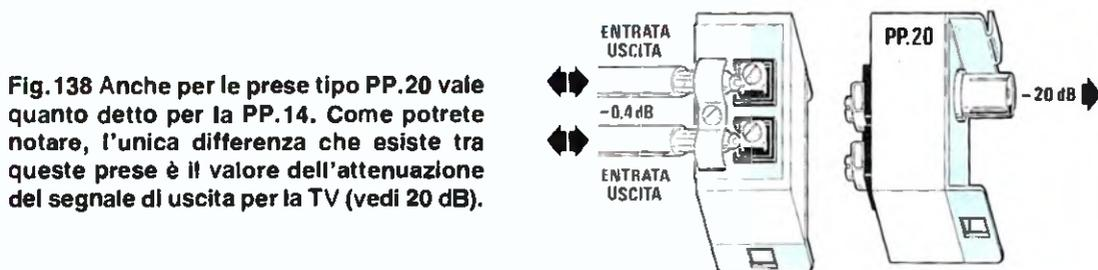
**Fig.138** Anche per le prese tipo PP.20 vale quanto detto per la PP.14. Come potrete notare, l'unica differenza che esiste tra queste prese è il valore dell'attenuazione del segnale di uscita per la TV (vedi 20 dB).
