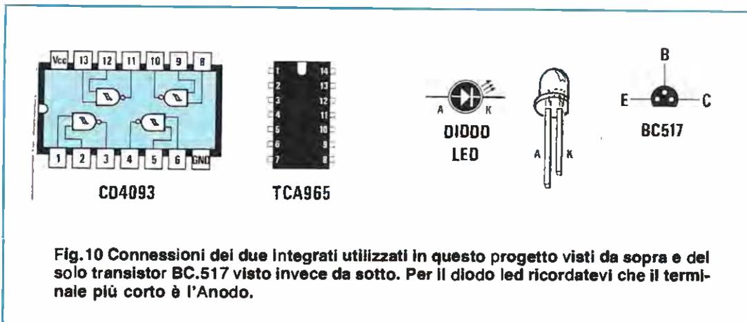
Fig.10 Connessioni dei due integrati utilizzati in questo progetto visti da sopra e del solo transistor BC.517 visto invece da sotto. Per il diodo led ricordatevi che il terminale più corto è l'Anodo.
