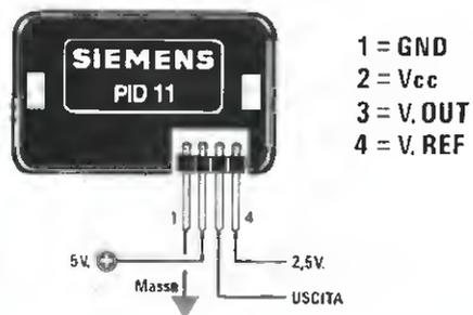
Fig.4 Dei quattro terminali che fuoriescono dalla parte posteriore del sensore, i due di sinistra servono per alimentare con una tensione di 5 volt il circuito interno, mentre i due di destra, per prelevare il segnale di "uscita" e la tensione di riferimento.
