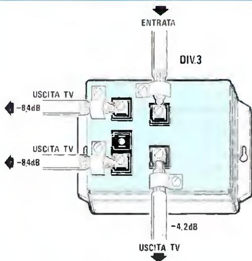
Fig.113 In un DIV.3 sono presenti una presa d'ingresso e tre uscite. I numeri negativi riportati sulle tre uscite indicano le attenuazioni di passaggio, cioè di quanti dB il segnale applicato sull'ingresso risulterà attenuato sulle tre diverse uscite.
