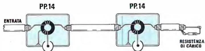
**Fig. 147** Poichè l'uscita "passante" dell'ultimo Derivatore (vedi fig. 144) o di una Pressa Passante rimarrebbe aperta, condizione questa che potrebbe causare delle riflessioni sulle Immagini, dovrete sempre ricordarvi di chiuderla con un carico resistivo da 75 ohm. Se non troverete una simile resistenza, potrete utilizzare due resistenze da 150 ohm poste in parallelo.
