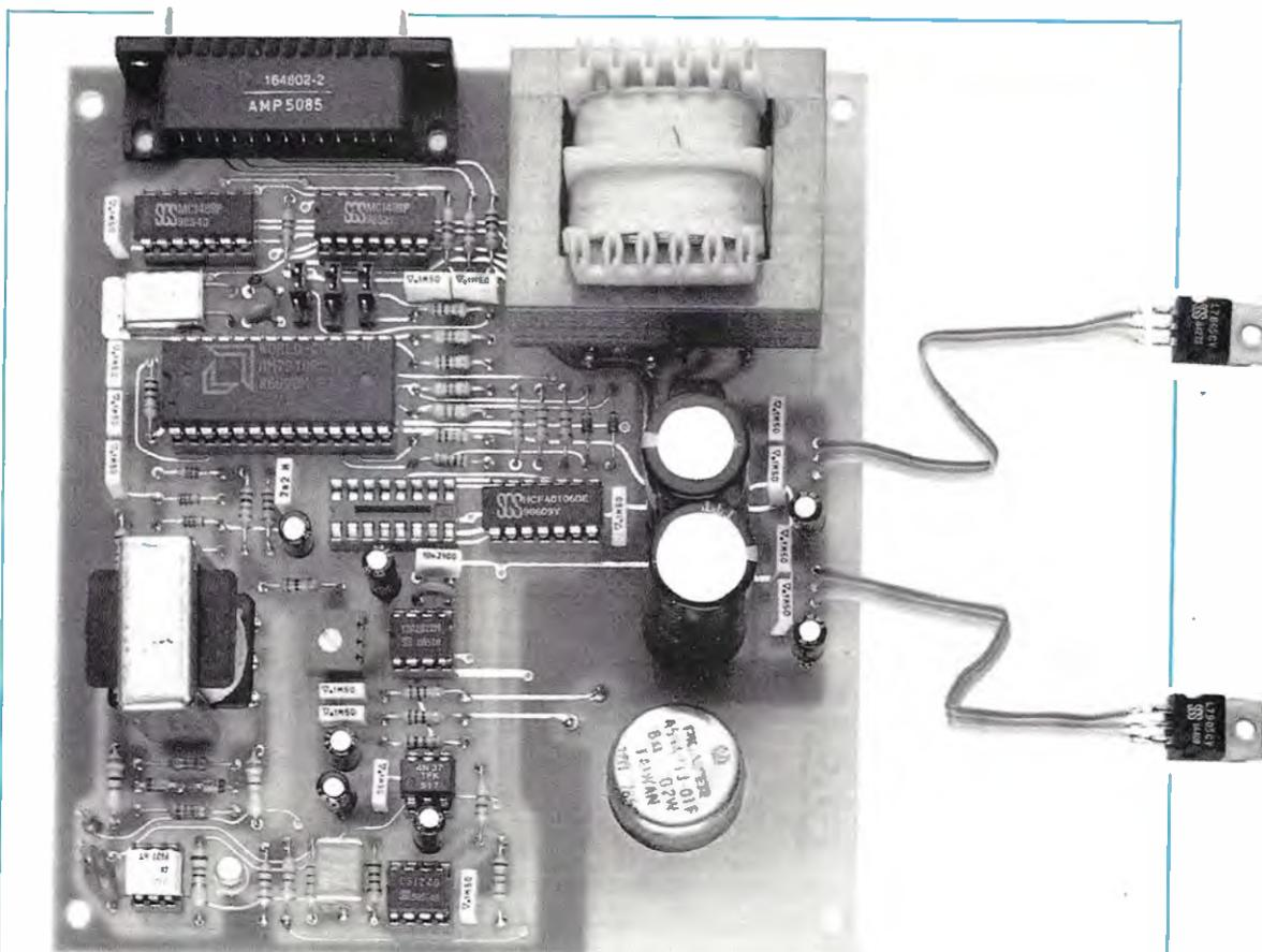
**Fig.2** Il montaggio di questo Modem è semplice perchè, sul circuito stampato, è presente un disegno serigrafico con tutti i simboli e le sigle dei vari componenti. In questa foto tale disegno serigrafico non appare perchè, negli esemplari che utilizziamo per il collaudo, ci è comodo avere tutte le piste libere.
