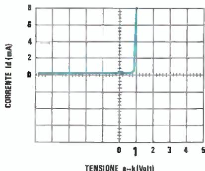
Fig.10 Un diodo al silicio introduce sempre una caduta di tensione di circa 0,6 - 0,7 volt e tale caduta rimane costante all'aumentare della corrente di lavoro.
