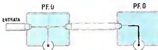
Fig.146 Sostituendo la prima presa con una PP.4,2, potrete collegare subito dopo questa una PF.0, perchè i disturbi spurii presenti su una delle due prese non potranno mai passare da una presa all'altra.
