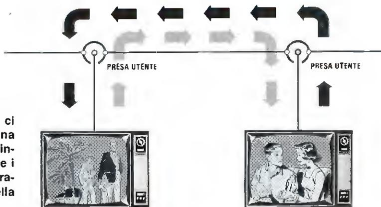
Fig.142 La stessa Presa ci deve altresì assicurare una elevata "attenuazione inversa", onde evitare che i segnali di disturbo generati da una TV rientrino nella linea principale.
