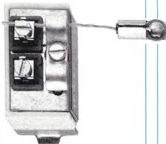
**Fig. 148** Le resistenze di carico da 75 ohm da inserire nei morsetti di uscita, possono avere forme e supporti diversi a seconda della Casa che le costruisce. In figura, un modello molto pratico ed economico che verrà bloccato dal serracavo.
