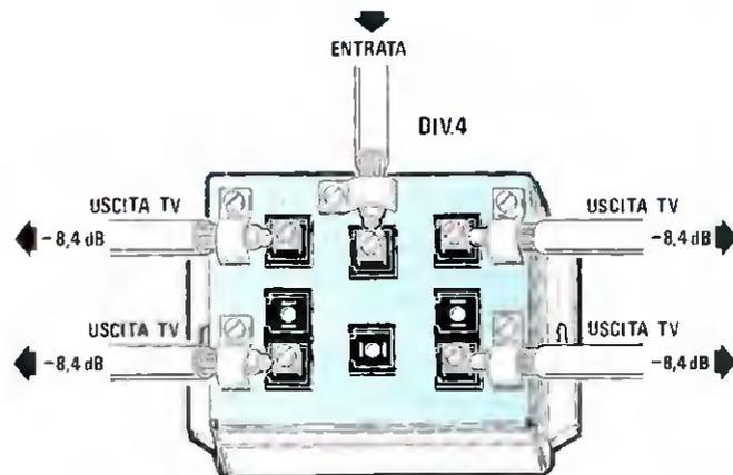
Logicamente, se sull'ingresso di questi Divisori applicheremo segnali di ampiezza diversa, pari ad esempio a 93 - 96 - 100 dBmicrovolt, sulle uscite preleveremo un segnale minore di -4,2 o -8,4 rispetto a quello inserito.
