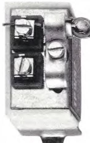
**Fig. 149** Infilato il terminale nel morsetto, dovrete tranciare il filo eccedente. Se avete difficoltà a trovare una simile resistenza, come già accennato, potrete utilizzare due resistenze da 150 ohm 1/4 watt, collegandole in parallelo così da ottenere 75 ohm.
