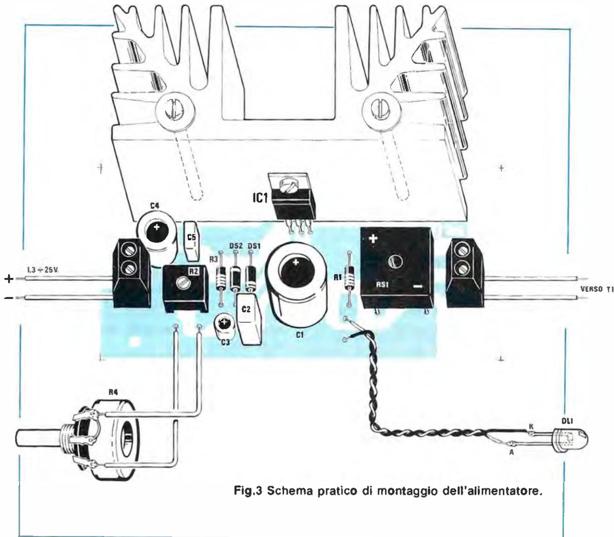
Fig.3 Schema pratico di montaggio dell'alimentatore.
