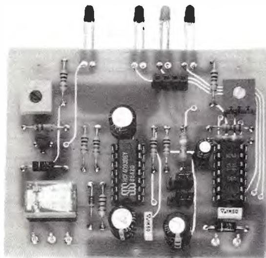
**Fig. 7** Come illustrato in questa foto, sull'area di circuito stampato sottostante al sensore, dovrete saldare i diodi di controllo. Il diodo DL4 ci conferma quando l'antifurto è alimentato.
