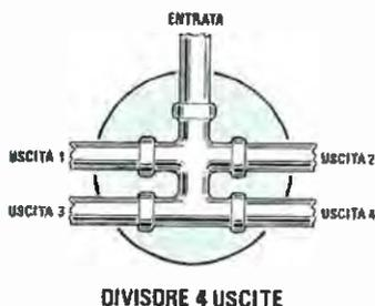
**Fig.106** Nel condomini con più appartamenti per ogni piano, può risultare necessario un Divisore con 4 uscite, tutte con identico diametro per evitare perdite di pressione.
