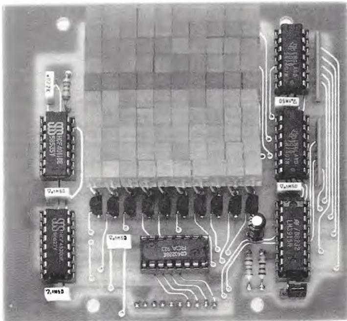
Fig.1 Con dieci colonne di diodi potrete visualizzare tutta la gamma delle frequenze acustiche e stabilire l'intensità del segnale per le diverse ottave. Nel prossimo numero vi insegneremo come trasformare questo circuito in fonometro per poter così equalizzare un ambiente.
