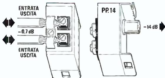
**Fig.137** Per le prese tipo PP.14 il segnale di ingresso e quello di proseguimento per la successiva presa, possono essere indifferentemente collegati sia al morsetto posto in alto che a quello posto in basso.
