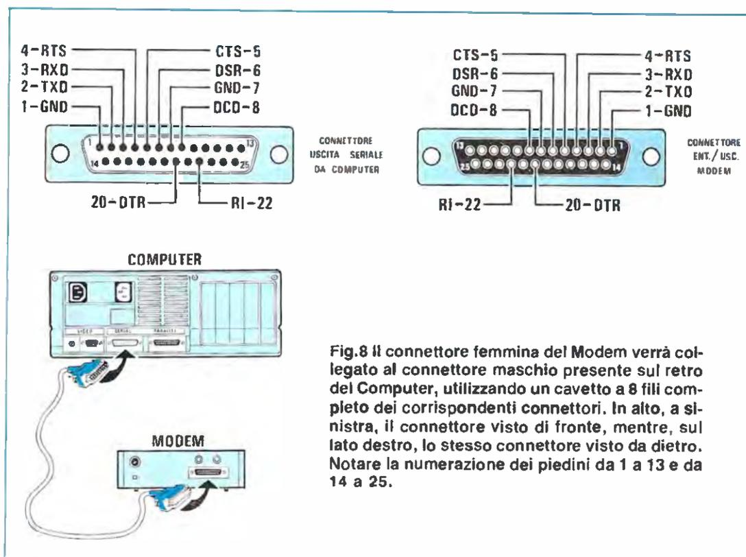
Fig.8 Il connettore femmina del Modem verrà collegato al connettore maschio presente sul retro del Computer, utilizzando un cavetto a 8 fili completo dei corrispondenti connettori. In alto, a sinistra, il connettore visto di fronte, mentre, sul lato destro, lo stesso connettore visto da dietro. Notare la numerazione dei piedini da 1 a 13 e da 14 a 25.
