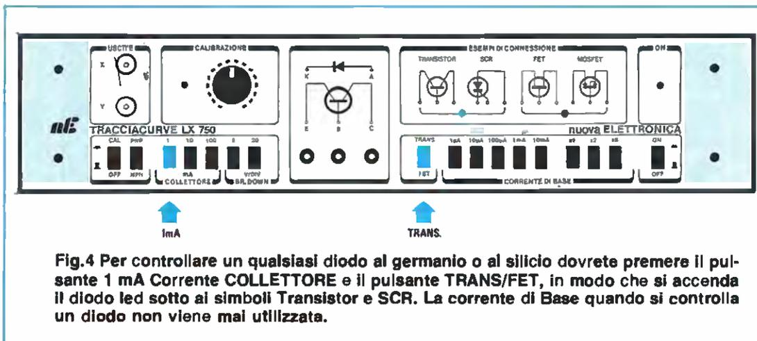
**Fig.4** Per controllare un qualsiasi diodo al germanio o al silicio dovreste premere il pulsante 1 mA Corrente COLLETTORE e il pulsante TRANS/FET, in modo che si accenda il diodo led sotto ai simboli Transistor e SCR. La corrente di Base quando si controlla un diodo non viene mai utilizzata.
