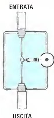
**Fig.130** Le prese di tipo Resistivo anche se più economiche, le dovrete scartare perchè presentano una attenuazione inversa insufficiente.
