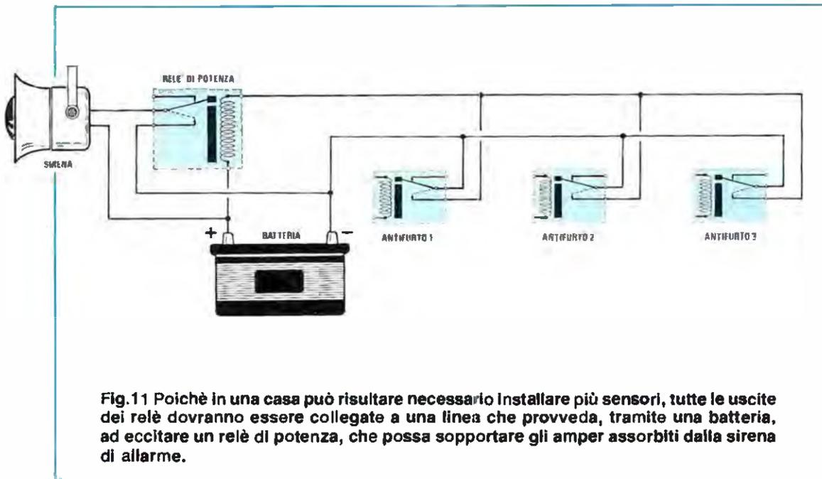
Fig.11 Poichè in una casa può risultare necessario installare più sensori, tutte le uscite dei relè dovranno essere collegate a una linea che provveda, tramite una batteria, ad eccitare un relè di potenza, che possa sopportare gli amper assorbiti dalla sirena di allarme.
