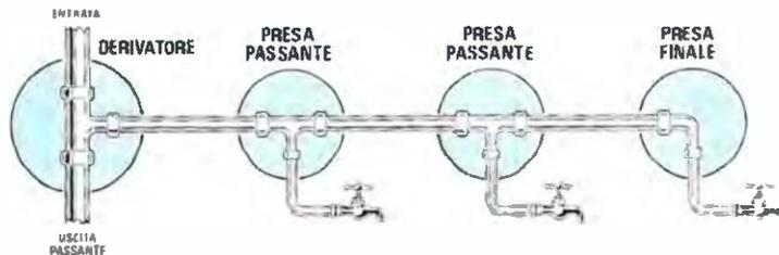
**Fig.108** Dal **Derivatore** partirà il tubo che porterà l'acqua a tutti i rubinetti. Se dal primo rubinetto dovrete proseguire ad un secondo, dovrete necessariamente inserire un raccordo a **L**, perchè qui ha termine l'impianto.
