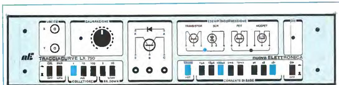
Fig.17 Per provare un transistor "unigiunzione" dovrete premere sul tracciacurve i pulsanti indicati con una freccia in colore, predisponendo l'oscilloscopio come spiegato nell'articolo.
