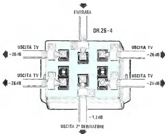
Fig.128 In un Derivatore modello DR.26-4 sono presenti una presa di ingresso, quattro uscite TV ed una di passaggio. L'attenuazione di passaggio (vedi uscita in basso) risulta per questo modello pari a 1,2 dB.
