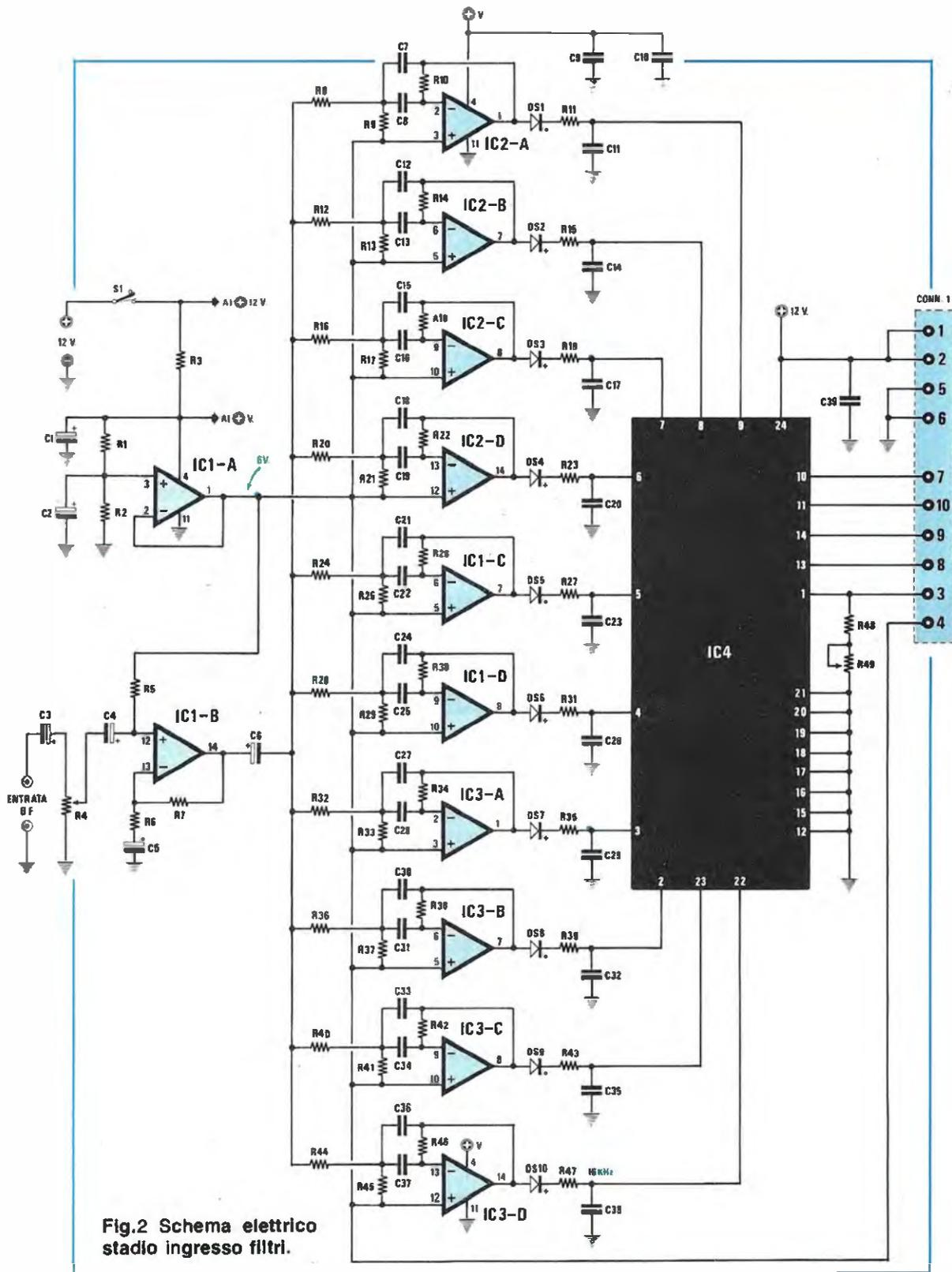
Fig.2 Schema elettrico stadio ingresso filtri.
