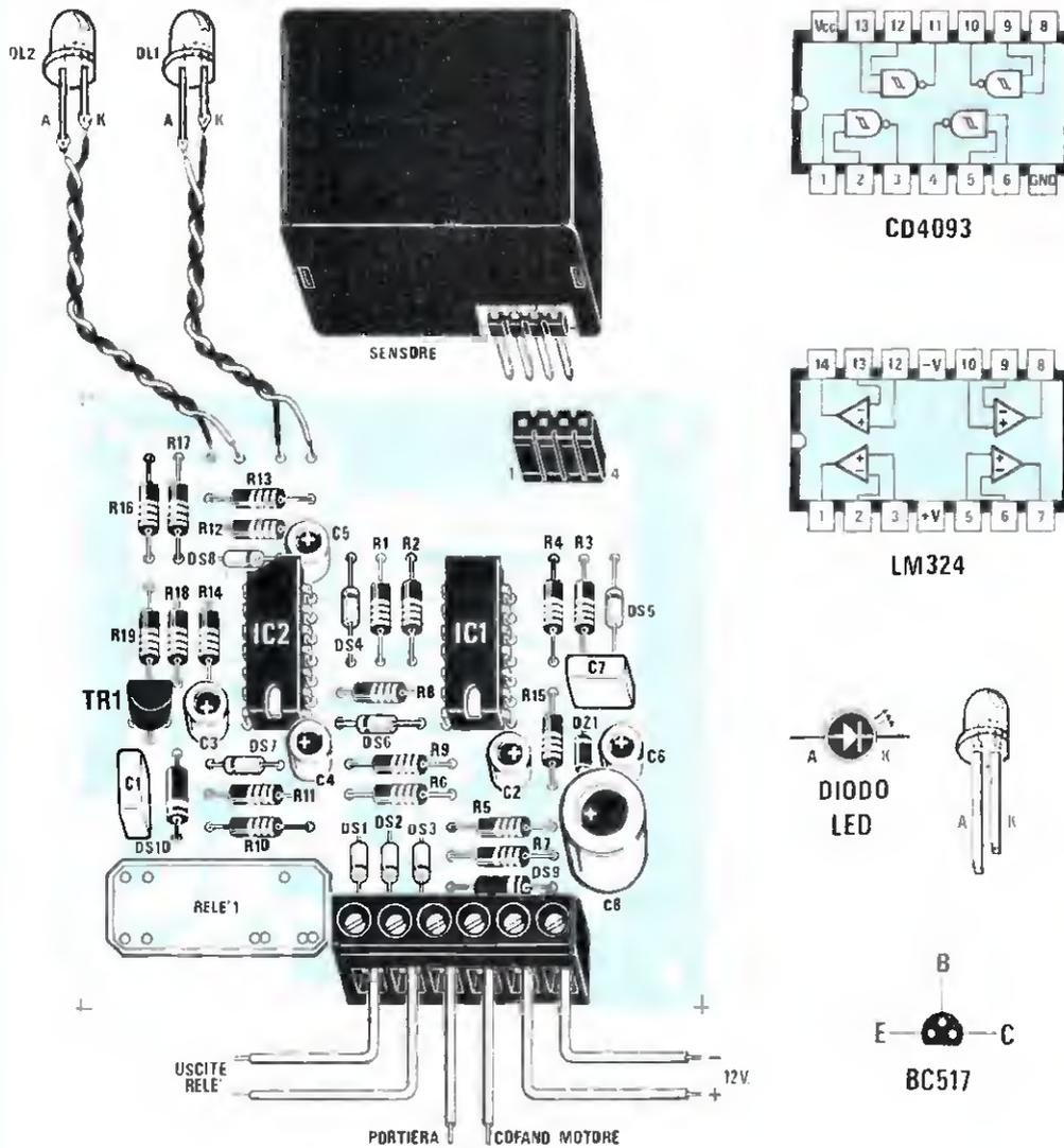
Fig.3 Schema pratico del nostro antifurto per auto, più le connessioni degli integrati, del transistor Darlington BC.517 e dei diodi led. La morsetteria visibile in basso servirà per collegare i fili di alimentazione, quelli di uscita del relè e quelli che dovrete congiungere al pulsante S2 della portiera e al pulsante S3 del cofano o del bagagliaio (vedi fig.2).
