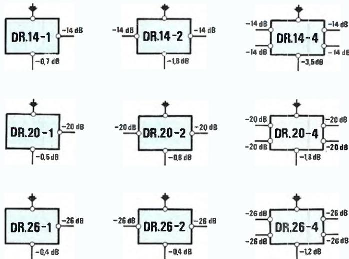
Derivatori con 1-2-4 uscite, tutte con attenuazioni di prelievo di -14 dB.
