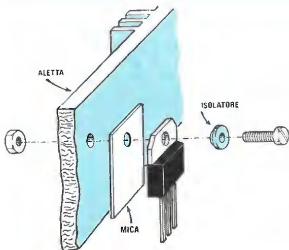
Fig.7 Poichè il terminale "E" dell'integrato uA.7905, risulta collegato al metallo del corpo, quando lo fissere-
