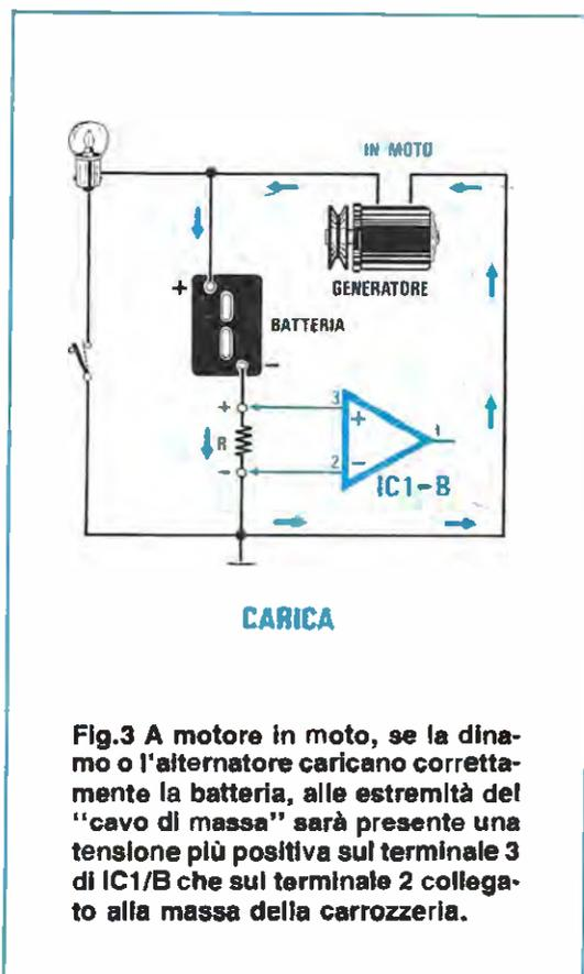
**Fig.3** A motore in moto, se la dinamo o l'alternatore caricano correttamente la batteria, alle estremità del "cavo di massa" sarà presente una tensione più positiva sul terminale 3 di IC1/B che sul terminale 2 collegato alla massa della carrozzeria.
