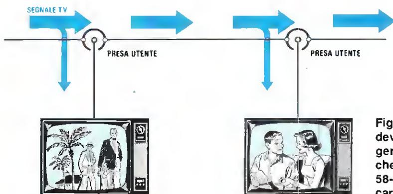
Fig.141 Una Presa Utente ci deve permettere di far giungere sulle TV un segnale che risulti compreso tra i 58-65 dBmicrovolt, senza caricare la linea principale.
