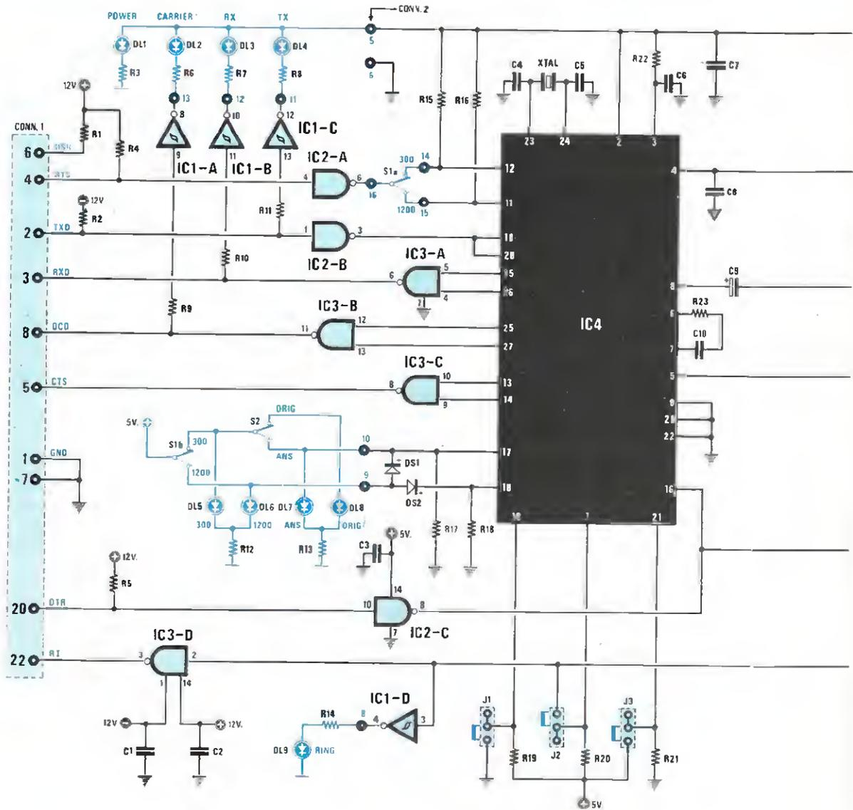
Fig.1 Schema elettrico completo del nostro Modem che, potendo lavorare da 300 Baude a 1.200 Baude, vi permetterà di collegarvi con qualsiasi utente sia in Half-Duplex che in Full-Duplex, in CCITT-V.21, CCITT-V.23, BELL-103, BELL-202. Questo Modem, come spiegato nell'articolo, dispone di un AUTO-TEST. La lista dei componenti è riportata a pag.83.
