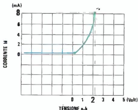
Fig.11 Un diodo al germanio introduce una caduta di tensione di 0,02 volt se la corrente di lavoro è minore di 0,5 milliamper, ma sale a circa 2 volt con correnti di 8 mA.
