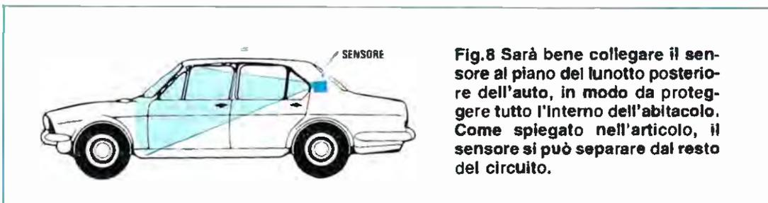
**Fig.8** Sarà bene collegare il sensore al piano del lunotto posteriore dell'auto, in modo da proteggere tutto l'interno dell'abitacolo. Come spiegato nell'articolo, il sensore si può separare dal resto del circuito.
