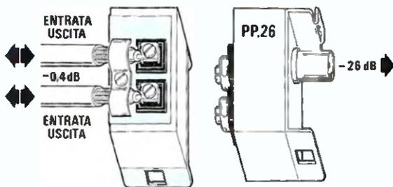
**Fig.139** Quanto detto poc'anzi, vale pure per la presa tipo PP.26. Su ogni presa troverete indicati anche i dB di attenuazione di passaggio.
