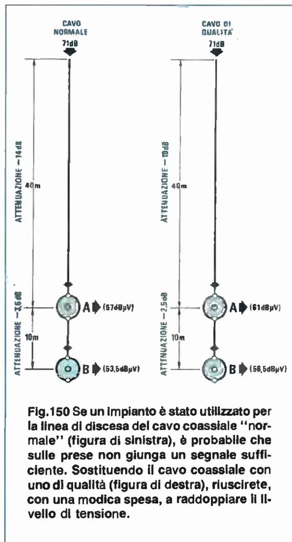
Fig. 150 Se un impianto è stato utilizzato per la linea di discesa del cavo coassiale "normale" (figura di sinistra), è probabile che sulle prese non giunga un segnale sufficiente. Sostituendo il cavo coassiale con uno di qualità (figura di destra), riuscirete, con una modica spesa, a raddoppiare il livello di tensione.
