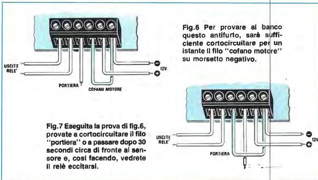
Fig.6 Per provare al banco questo antifurto, sarà sufficiente cortocircuitare per un istante il filo "cofano motore" su morsetto negativo.
