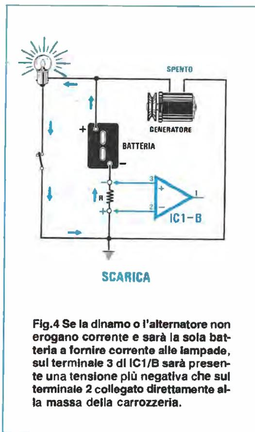
**Fig.4** Se la dinamo o l'alternatore non erogano corrente e sarà la sola batteria a fornire corrente alle lampade, sul terminale 3 di IC1/B sarà presente una tensione più negativa che sul terminale 2 collegato direttamente alla massa della carrozzeria.
