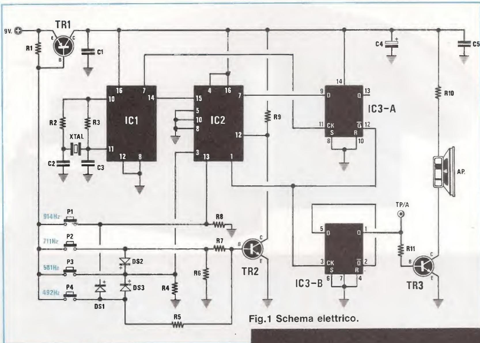
Fig.1 Schema elettrico.
