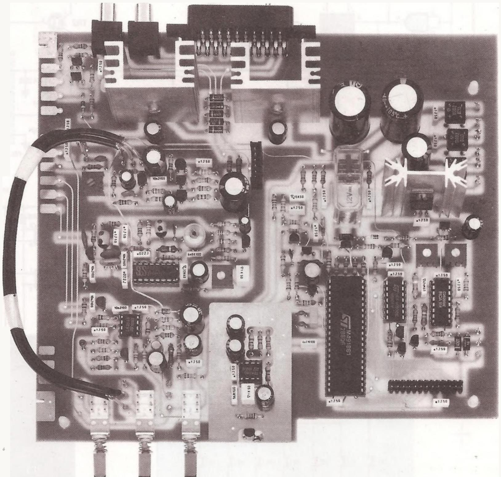
**Fig.1** Guardando questa foto potrete subito rendervi conto che montare il nostro ricevitore per captare le TV via satellite non è per nulla problematico. Vi raccomandiamo di eseguire delle perfette saldature, di "non allargare" alcun foro con punte da trapano, per non togliere dal loro interno lo strato metallizzato, che collega elettricamente le piste presenti su entrambi i lati del circuito stampato.
