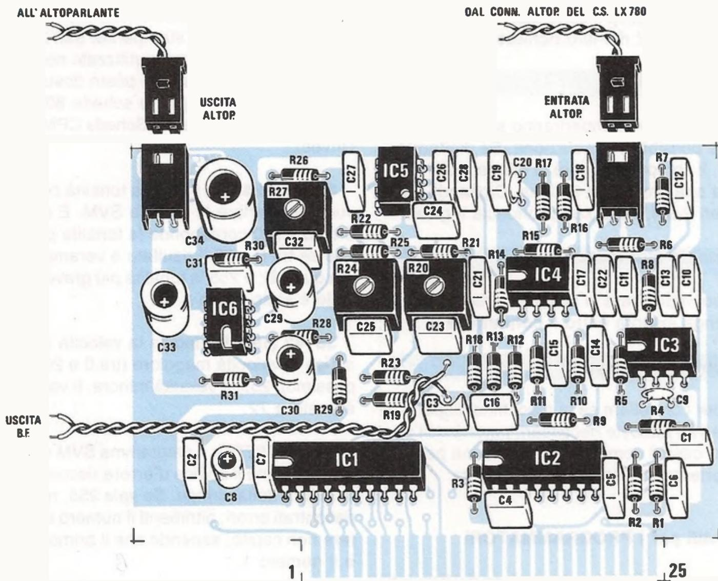
**Fig.6 Schema pratico di montaggio della scheda parlante-musicale. Il trimmer R27 serve per dosare il volume, mentre gli altri due siglati R20 - R24 servono per correggere la tonalità dei soli toni Medi e Bassi. Questi tre trimmer li tarerete ad orecchio, in modo da ottenere un suono di qualità. Assieme al kit vi verrà fornito un floppy-disk con i necessari programmi.**
