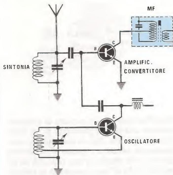
**Fig.6** Nelle prime supereterodine era presente un "transistor oscillatore" separato, in grado di generare una segnale di AF che, miscelato alla frequenza della emittente captata, dava sempre come differenza 455 KHz.
