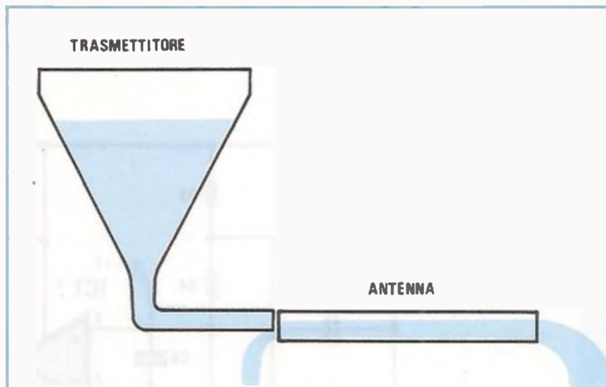
Fig.8 Per trasferire tutta l'energia erogata dal trasmettitore verso l'antenna, è indispensabile che l'impedenza di uscita del trasmettitore risulti perfettamente identica a quella dell'antenna, diversamente, parte dell'energia AF verrebbe dispersa.
