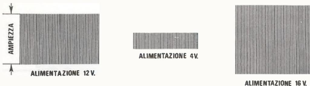
**Fig.5** Se verificaste con un oscilloscopio l'ampiezza di un segnale di Alta Frequenza erogata da un trasmettitore, alimentato con una tensione di 12 volt, potreste ottenere un segnale come visibile a sinistra. Abbassando la tensione a 4 volt, l'ampiezza di tale segnale si ridurrà, mentre alzandola a 16 volt questa ampiezza aumenterà rispetto a quella del 12 volt.
