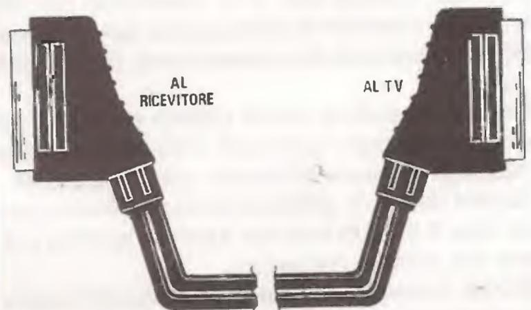
Fig.20 Per non invertire i due connettori, indicate sul loro corpo quello che va al TV e quello che va al ricevitore. Se volete ottenere un cavo bidirezionale, dovrete utilizzare altri due cavetti schermati e collegarli come vedesi in fig.19 (cavetti di colore blu).
