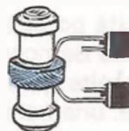
**Fig.9** Oggi, in sostituzione dei mastodontici condensatori variabili, vengono impiegati dei minuscoli "diodi varicap". Applicando ai capi di questi una tensione positiva, che potremo variare da minimo ad un massimo con un potenziometro, è possibile modificare la loro capacità.
