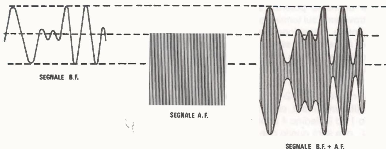
**Fig.6** Ponendo la tensione del segnale di BF in serie alla tensione di alimentazione di un qualsiasi trasmettitore, si otterrà un segnale di AF "modulato" in ampiezza, che rispetta fedelmente il valore massimo positivo e il negativo del segnale di BF utilizzato.
