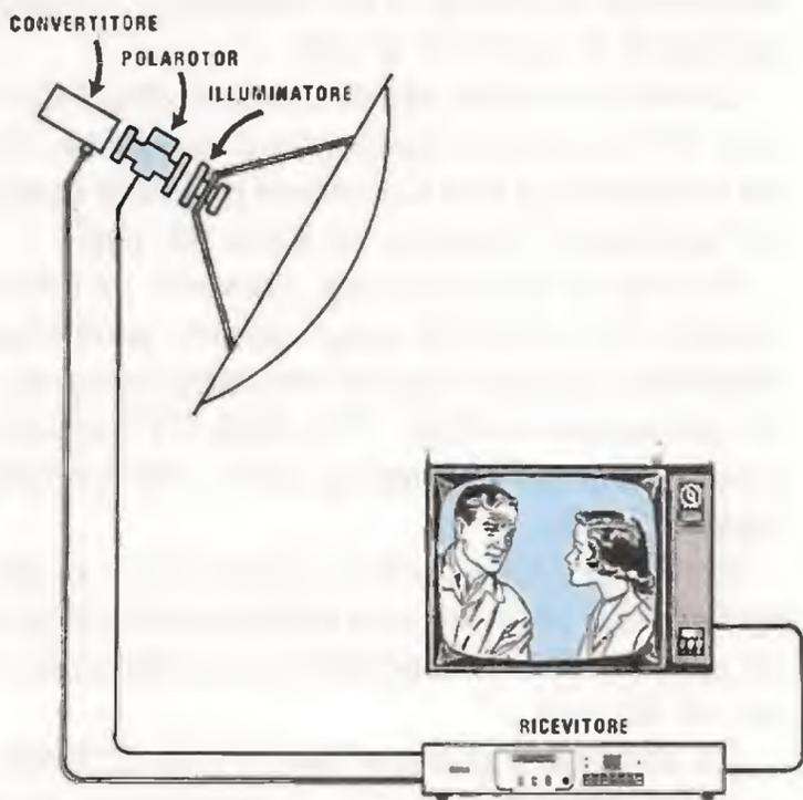
**Fig.5** Prima di fissare sul Convertitore LNC il Polarotor, che serve solo ed esclusivamente per passare dalla polarizzazione orizzontale a quella verticale o viceversa, sarebbe consigliabile centrare la parabola sul satellite, utilizzando il solo Convertitore. Captata una emittente, si fisserà la parabola in modo stabile, dopodichè si potrà inserire il Polarotor e tarare i due trimmer R2 - R5 per il massimo segnale, vale a dire fino ad ottenere una immagine perfetta senza tracce di rumore.
