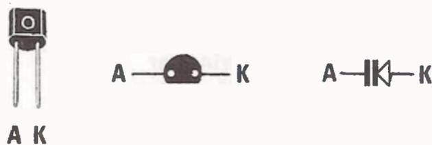
Fig.11 Il diodo varicap utilizzato in questo ricevitore porta la sigla MVAM.115 e come vedesi in disegno, possiede le stesse dimensioni e la stessa forma di un transistor plastico, e due soli terminali, indicati A-K, che non dovrete assolutamente invertire.
