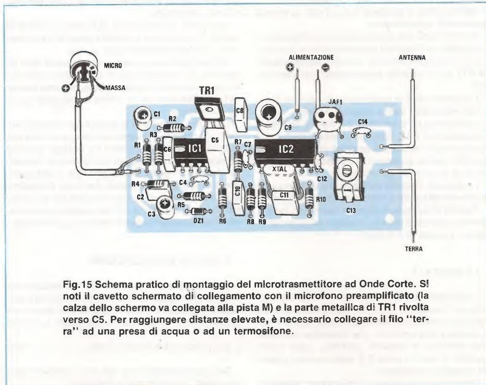
Fig.15 Schema pratico di montaggio del microtrasmettitore ad Onde Corte. Si noti il cavetto schermato di collegamento con il microfono preamplificato (la calza dello schermo va collegata alla pista M) e la parte metallica di TR1 rivolta verso C5. Per raggiungere distanze elevate, è necessario collegare il filo "terra" ad una presa di acqua o ad un termosifone.
