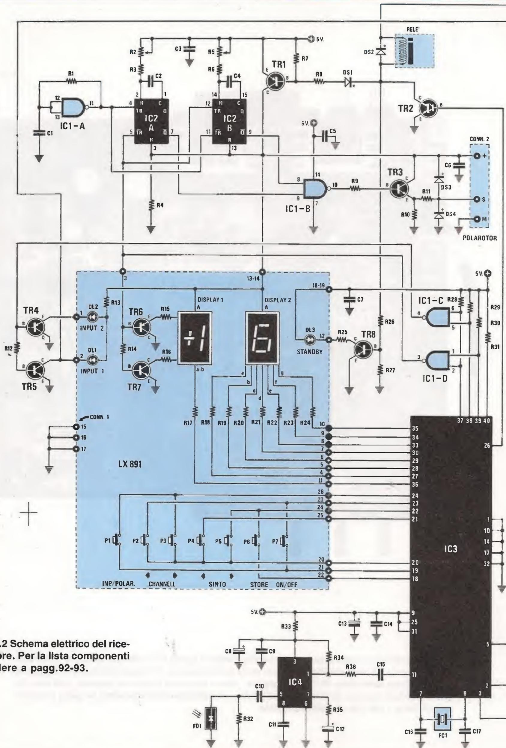
Fig.2 Schema elettrico del ricevitore. Per la lista componenti vedere a pagg.92-93.
