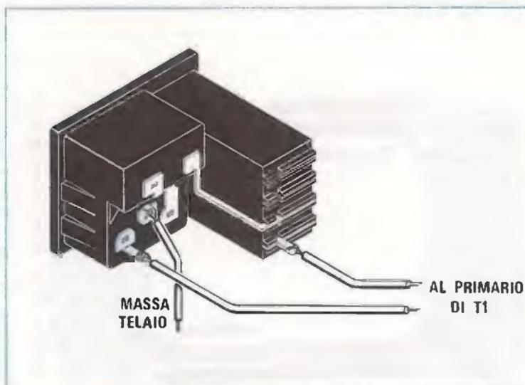
Fig.21 La presa rete che fisserete sul pannello posteriore del mobile, è completa dell'interruttore di accensione e di portafusibile. Non dimenticatevi di collegare con un filo il terminale visibile in disegno, alla "massa" metallica del mobile.
