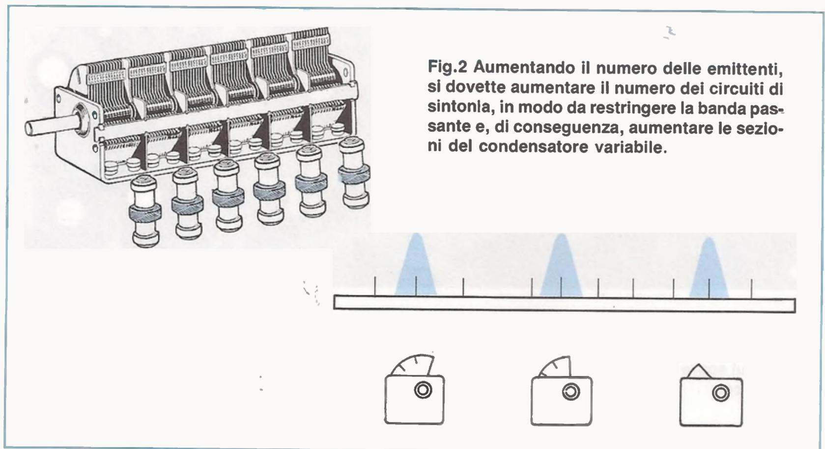
**Fig.2** Aumentando il numero delle emittenti, si dovette aumentare il numero dei circuiti di sintonia, in modo da restringere la banda passante e, di conseguenza, aumentare le sezioni del condensatore variabile.
