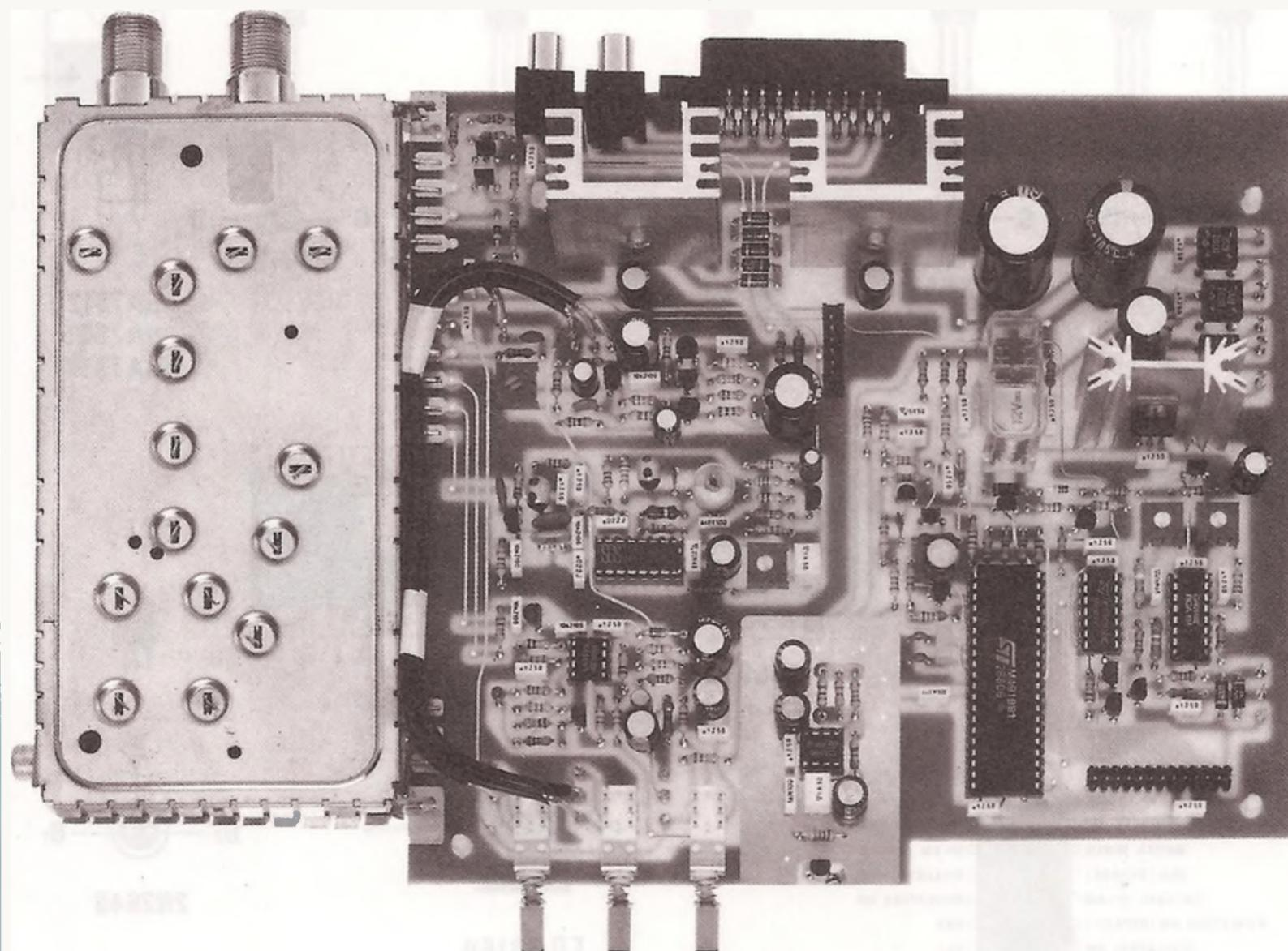
**Fig.9** Foto del circuito con già montato il gruppo UHF. Come potete notare sui tre integrati stabilizzatori andranno applicate le alette di raffreddamento, la cui forma appare ben evidente nella foto.
