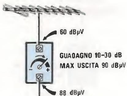
Fig.232 Se il segnale in antenna risulterà elevato, dovrete verificare che il segnale che otterrete sulla sua uscita non superi il "livello Max" consentito dal preamplificatore. Come noterete, su ogni preamplificatore è sempre presente un trimmer, che vi permetterà di regolare l'amplificazione da un minimo ad un massimo.
