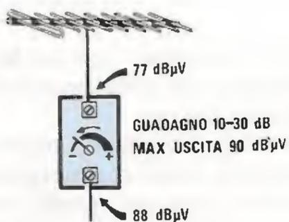
Fig.233 Pertanto, se disponete di un preamplificatore che riporta come "Max segnale in uscita 90 dBμV" e l'antenna già vi fornisce un segnale di 77 dBmicrovolt, dovrete ruotare tale trimmer in modo da ottenere in uscita non più di 88 dBmicrovolt, per evitare che sul televisore appaiano delle venature nel colore.
