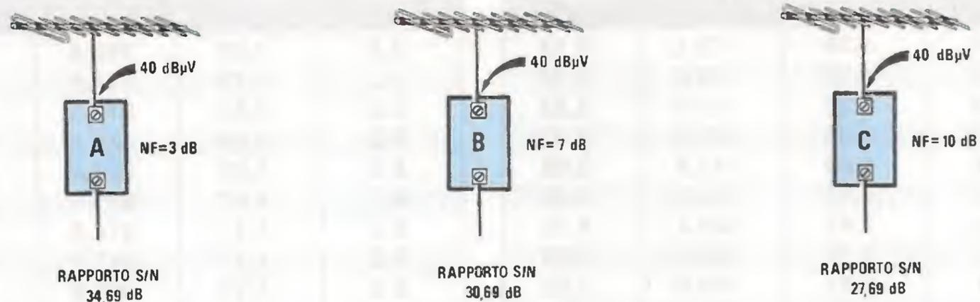
Fig.225 In presenza di segnali molto deboli, dovrete sempre scegliere dei preamplificatori con NF molto basse. Ad esempio, con un segnale in antenna di 40 dBmicrovolt, solo il preamplificatore che ha una NF di 3 dB vi potrà fornire una "immagine buona", gli altri due con una NF di 7 dB e 10 dB vi daranno immagini scadenti, perchè il rapporto S/N è minore di 30 dB.
