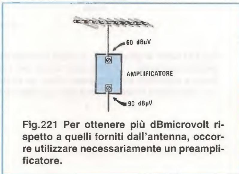
**Fig.221** Per ottenere più dBmicrovolt rispetto a quelli forniti dall'antenna, occorre utilizzare necessariamente un preamplificatore.
