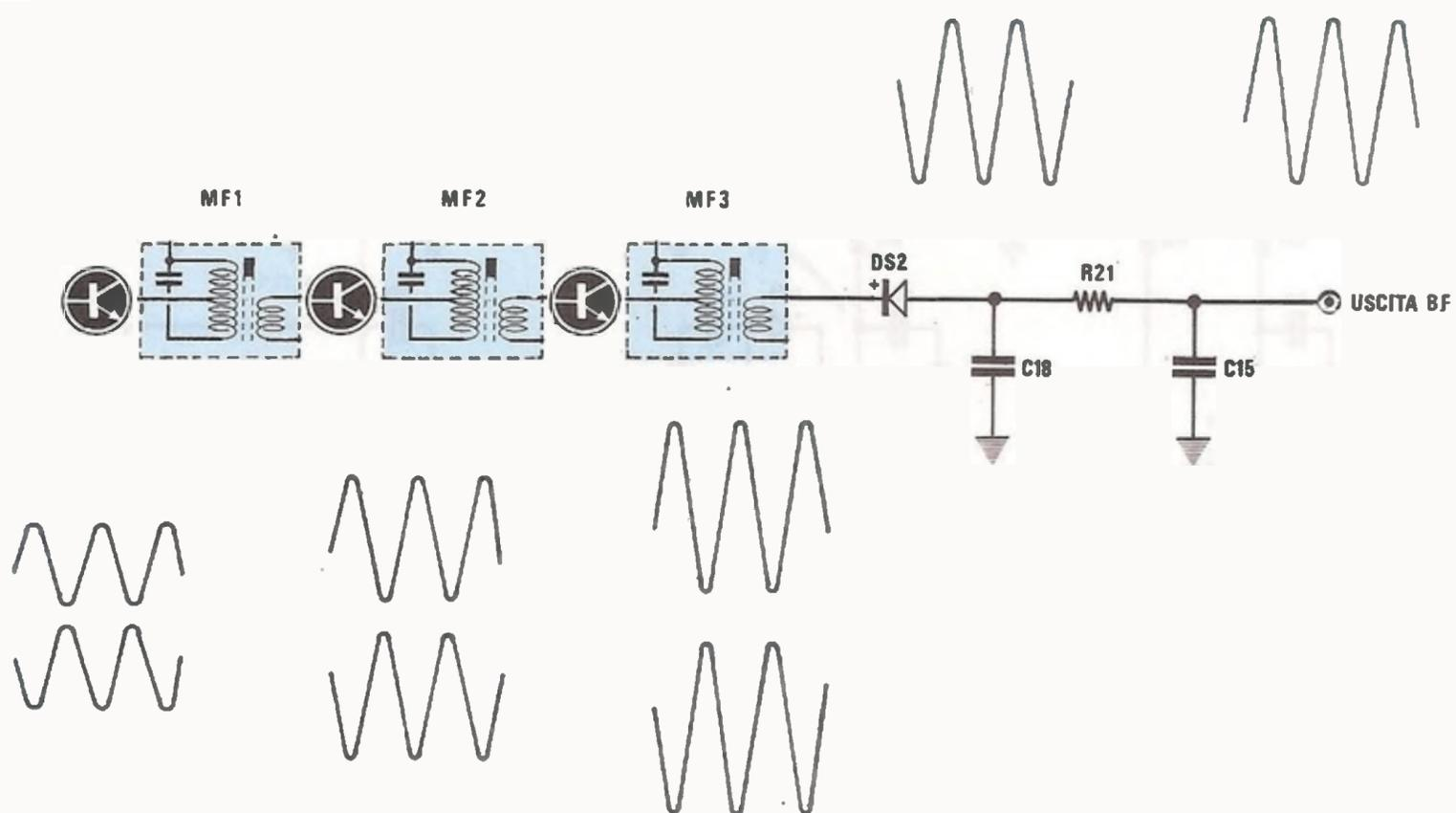
**Fig.13** Il segnale captato, convertito sulla frequenza di 455 KHz, verrà amplificato da due stadi di MF, poi applicato ad un diodo raddrizzatore al germanio DG2, che provvederà a lasciar passare le sole semionde "negative" dell'AF. Il condensatore C18, fuggendo a massa l'AF a 455 KHz, provvederà a separare da questa il solo segnale di BF.
