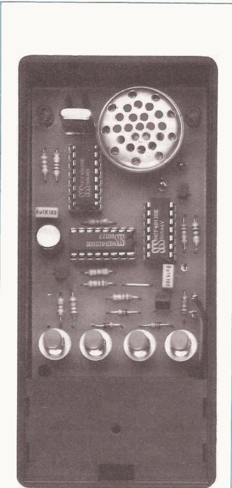
**Fig.8** Il trasmettitore verrà racchiuso entro un piccolo mobile plastico già completo di vano per contenere la pila da 9 volt (spazio visibile in basso). Poichè il suono non dispone di una elevata potenza, vi consigliamo di fissare il piccolo altoparlante direttamente sul pannello frontale del contenitore.
