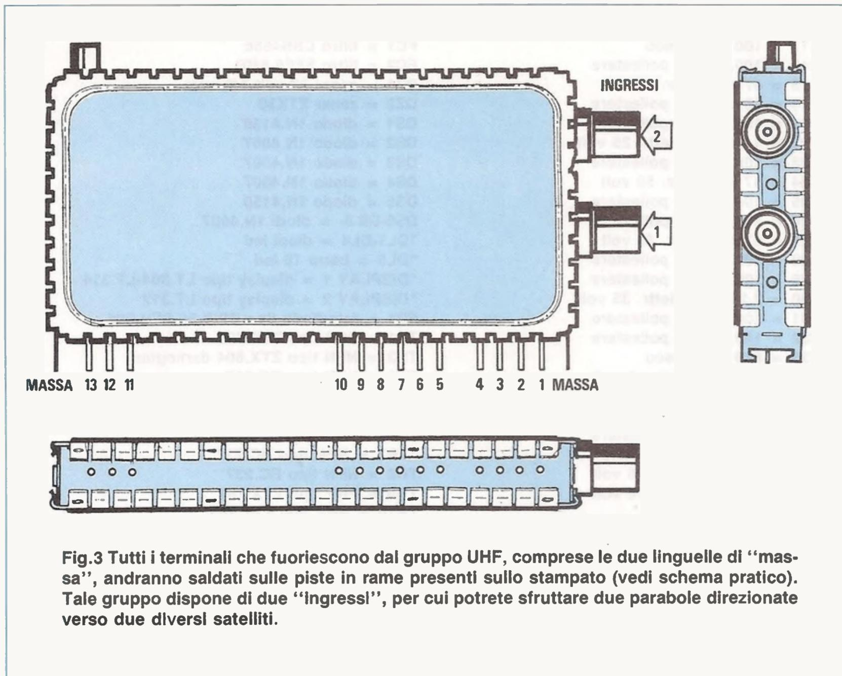
**Fig.3** Tutti i terminali che fuoriescono dal gruppo UHF, comprese le due linguette di "mas-sa", andranno saldati sulle piste in rame presenti sullo stampato (vedi schema pratico). Tale gruppo dispone di due "ingressi", per cui potrete sfruttare due parabole direzionate verso due diversi satelliti.
