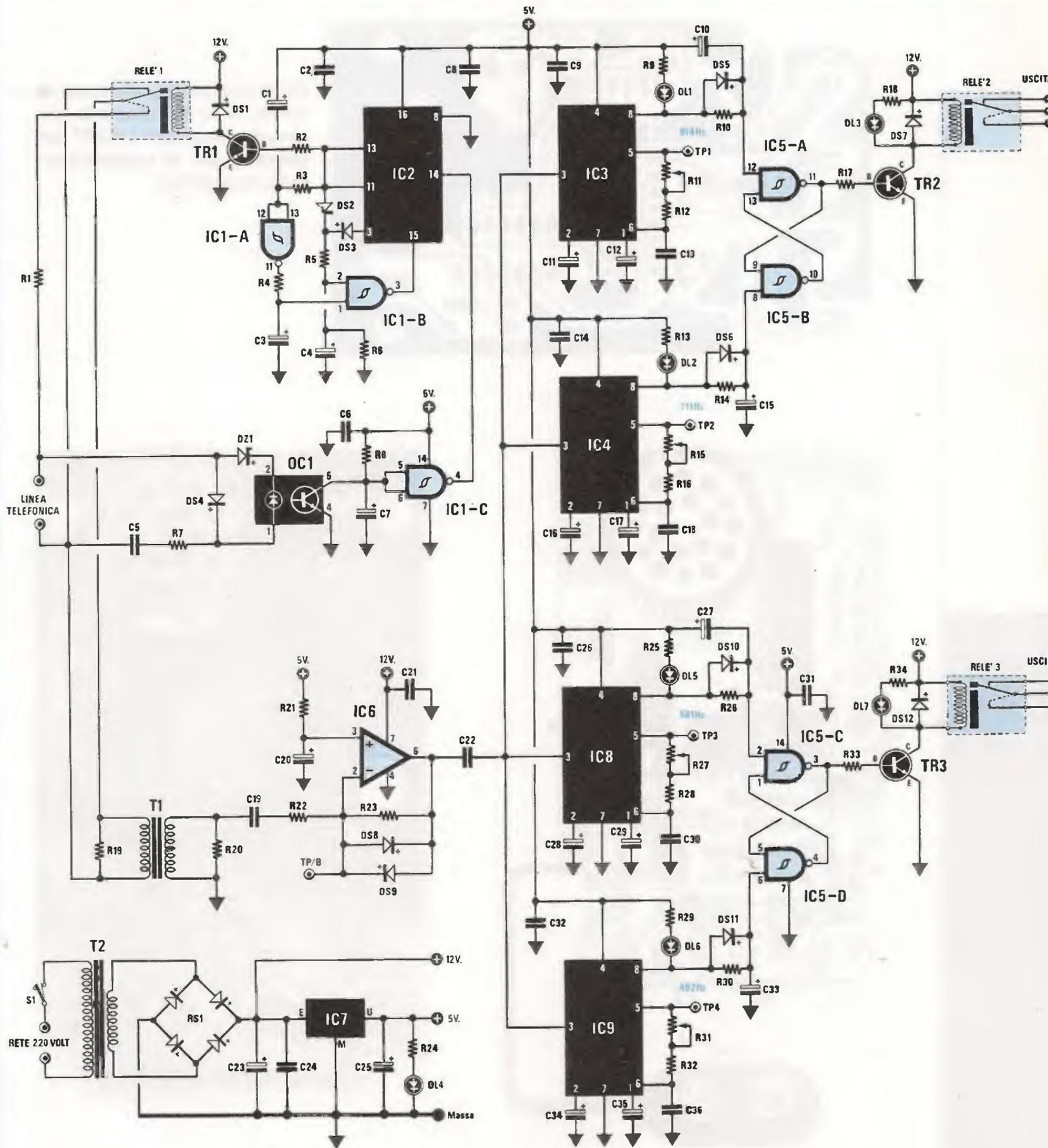
Fig.5 Schema elettrico completo dello stadio ricevente. Le due bocche, visibili sul lato sinistro dello schema, indicate "Linea Telefonica", andranno collegate in parallelo ai due fili del vostro apparecchio telefonico.
