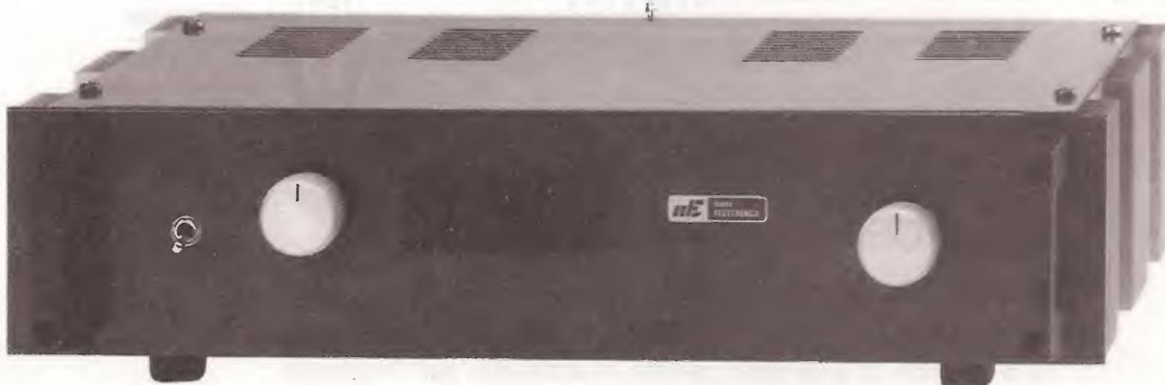
Il mobile che potrete richiedere per questo ricevitore vi verrà fornito con un pannello già forato e serigrafato (la foto è di un primo esemplare). L'asola per i display del frequenzimetro digitale è già completa di plexiglass rosso.
