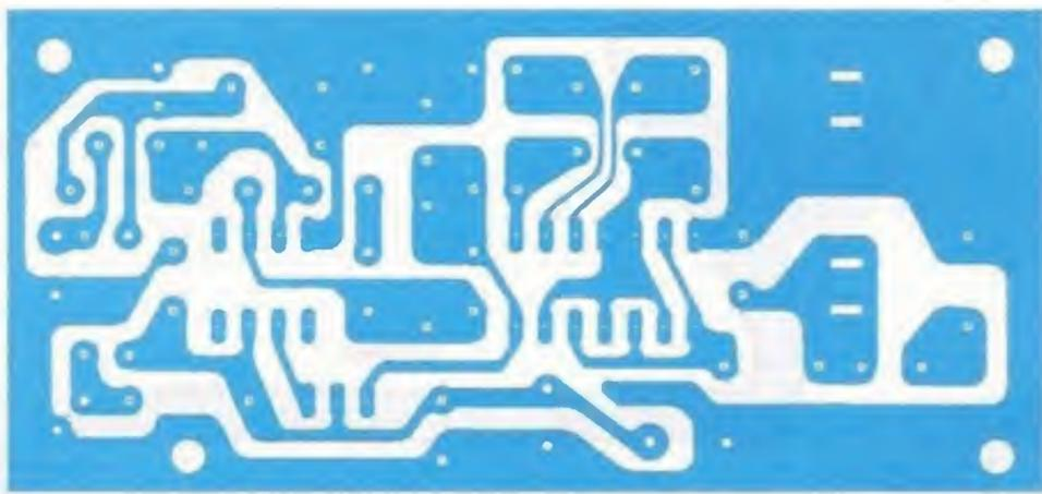
Fig.14 Disegno a grandezza naturale del circuito stampato LX.889, visto dal lato rame.
