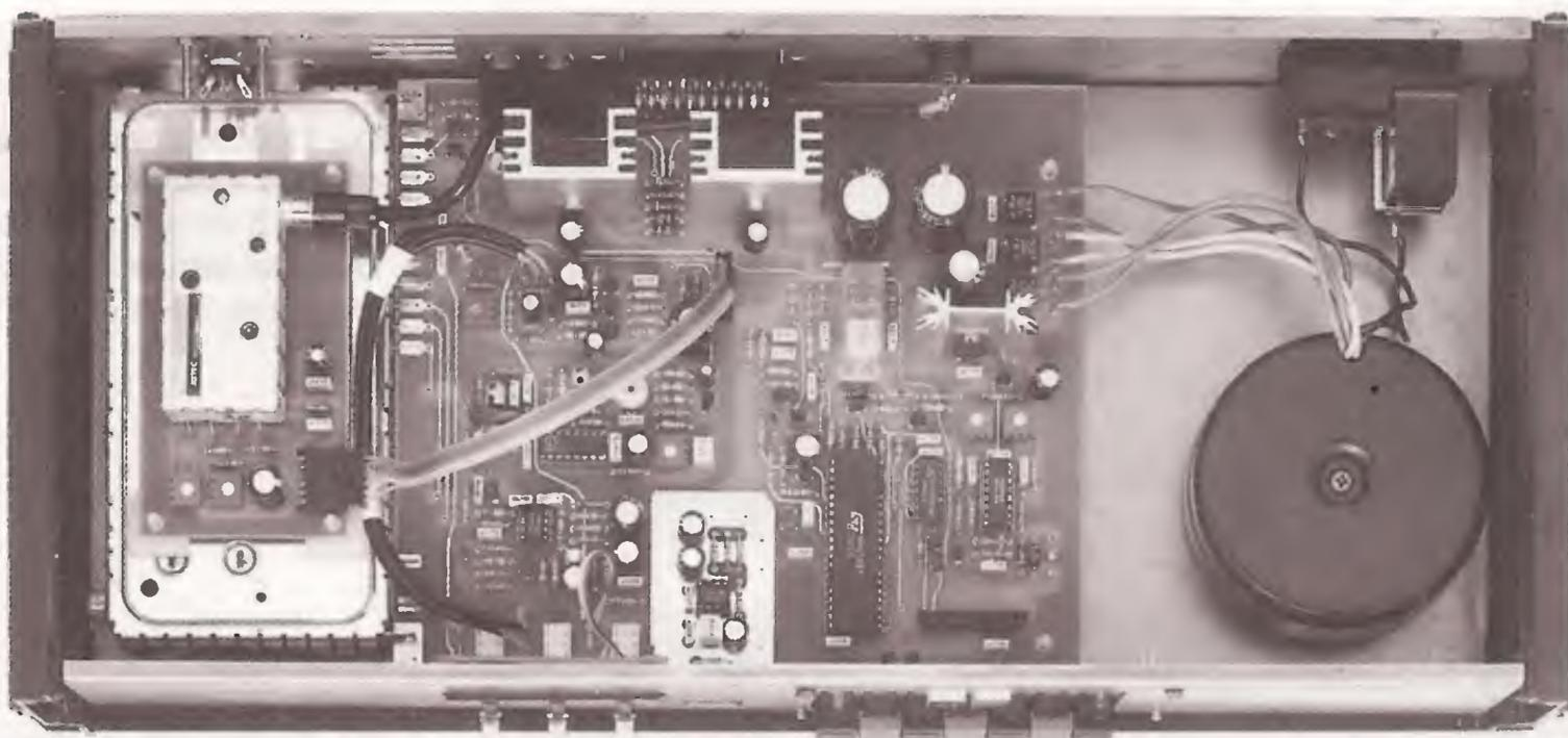
**Fig.16** In questa foto potete vedere come dovete disporre all'interno del mobile il circuito stampato base LX.890 e il trasformatore toroidale di alimentazione. In questa foto risulta già fissato sul gruppo UHF, il modulatore Video/Audio presentato a pag.112.
