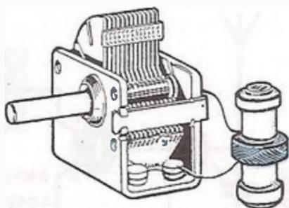
**Fig.8** Per ottenere un circuito di sintonia, occorre una bobina provvista di un certo numero di spire, con in parallelo un condensatore variabile in grado di modificare (per le Onde Medie) la sua capacità da un minimo di 24 pF ad un massimo di 250 pF.
