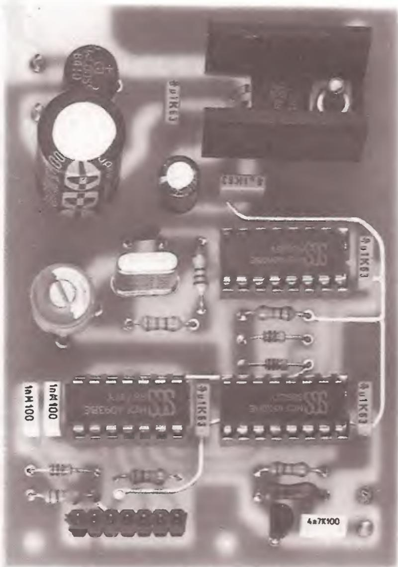
**Fig.8** Foto dello stadio base del frequenzimetro leggermente ingrandita. Si noti in basso a sinistra il connettore femmina che vi servirà per collegarvi, tramite una piastrina a 7 fili, al circuito dei display siglato LX.571 (vedi fig.9).
