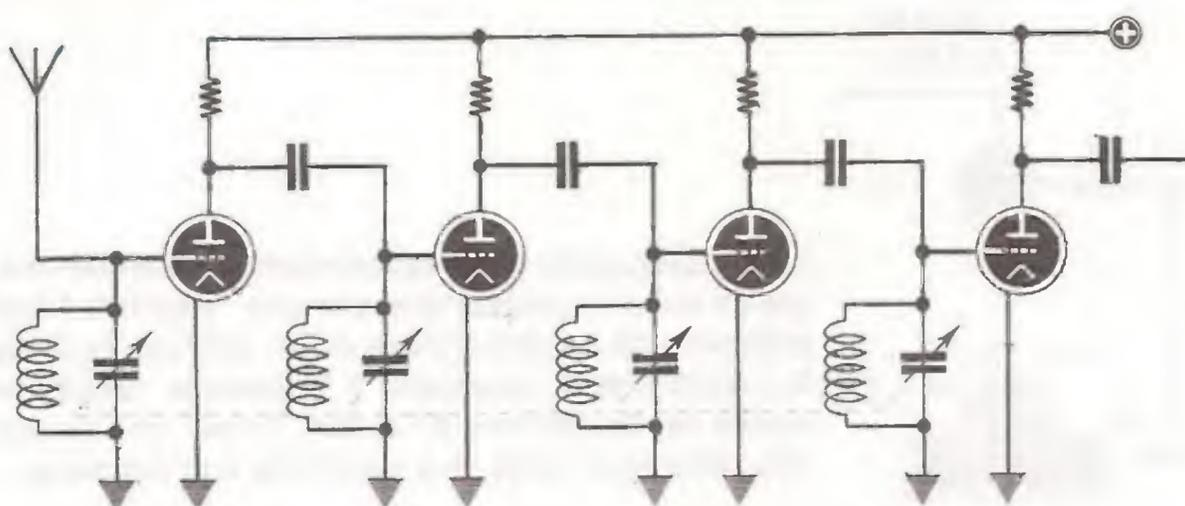
Fig.3 Nel primi ricevitori radio, anche applicando in ogni stadio amplificatore AF una bobina + condensatore variabile, la "selettività" oltre a non risultare ancora perfetta, rendeva questi ricevitori molti critici da tarare, quindi si cercò di trovare una diversa soluzione di questo inconveniente.
