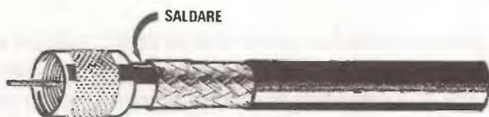
Fig.23 Una volta infilato il cavo tanto da far fuoriuscire il filo centrale che userete come spinotto, dovrete saldare la calza metallica sulla massa del connettore come visibile in disegno.
