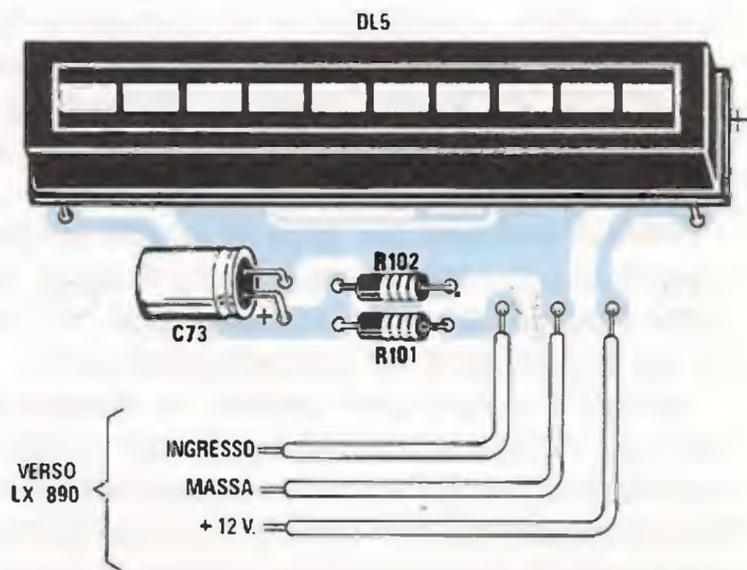
Fig.11 Di lato, lo schema pratico del circuito LX.191/B con già sopra montata la barra a diodi led. Questa barra vi permetterà di conoscere approssimativamente la frequenza di sintonia. Infatti il primo led a sinistra si accenderà sui 950 MHz ed il decimo led a destra sui 1.750 MHz.
