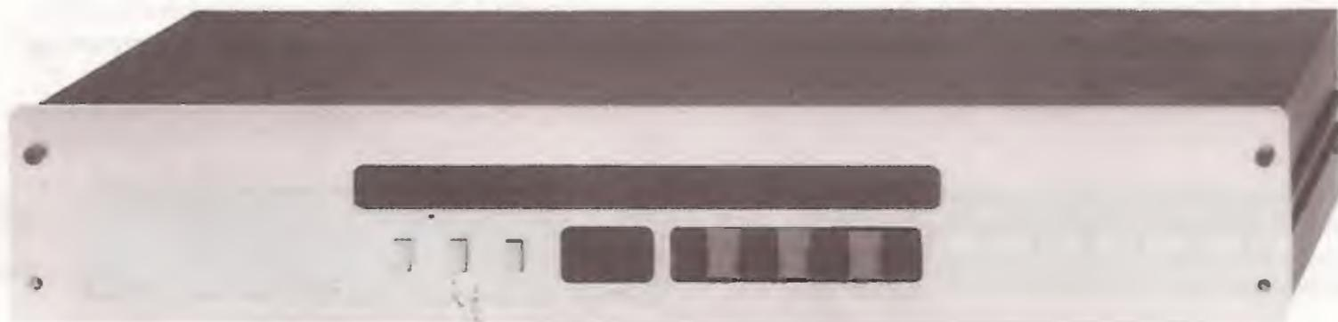
**Fig.18** Il pannello frontale qui fotografato, è ancora privo di disegno serigrafico. Nell'asola superiore e in quella posta di fronte al fotodiiodo del telecomando, è già presente un plexi-glass colorato.
