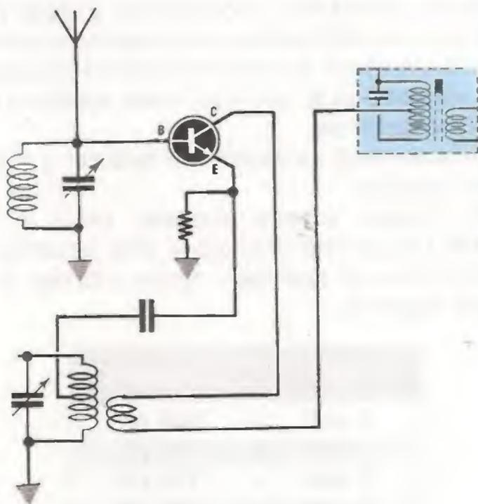
**Fig.7** In seguito si scoprì che lo stesso transistor preamplificatore AF, poteva essere sfruttato anche come 'stadio oscillatore-convertitore, se lo schema fosse stato modificato come vedesi in figura. Così facendo, si poteva risparmiare un transistor, senza pregiudicarne il funzionamento.
