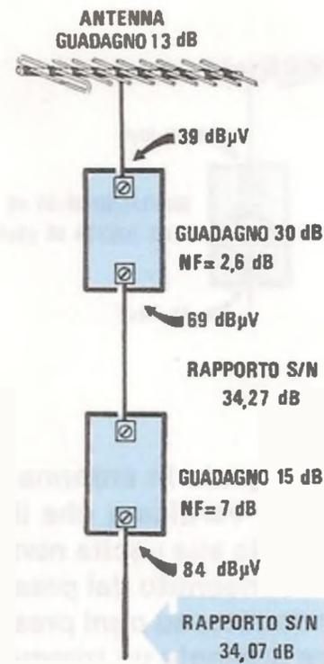
**Fig.231** Nelle zone marginali, dove il segnale giunge minore di 40 dBmicrovolt, è assolutamente necessario inserire come primo stadio un preamplificatore "Super Low-Noise", con una NF minore di 3 dB. Sull'uscita di questo potrete poi collegare un qualsiasi preamplificatore ad alto guadagno, in grado di fornire i dBmicrovolt richiesti.
