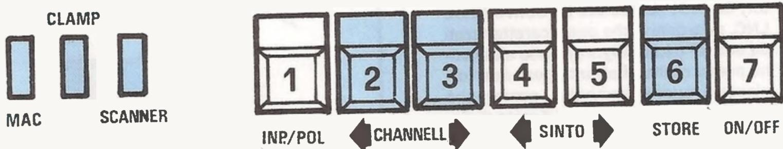
**Fig.4** Sul lato sinistro del pannello frontale di questo ricevitore troverete i commutatori di Mac-Clamp-Scanner, e sul lato destro i pulsanti delle funzioni. Quando si inserirà lo "Scanner", automaticamente tutti i pulsanti di funzione, rimarranno inattivi.
