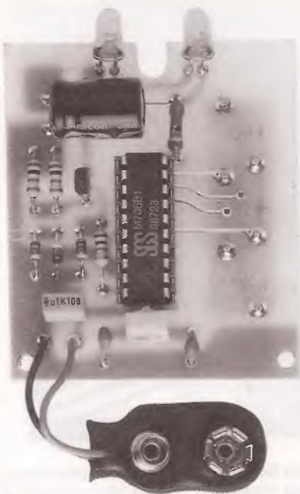
Fig.26 Schema pratico di montaggio del telecomando a raggi infrarossi LX.892. Prima di montare i due diodi emittenti LD.271, ripiegate i terminali a L controllando che il terminale più lungo "A" risulti per ognuno rivolto verso destra. Se uno dei due diodi venisse collegato in senso opposto, il circuito non funzionerebbe.
