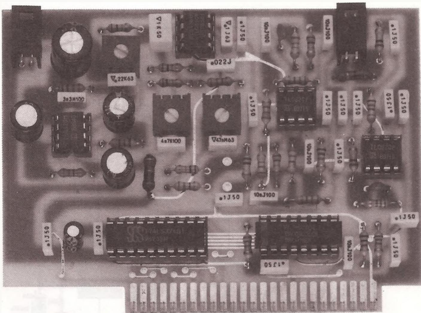
**Fig.4** Ecco come si presenta a montaggio ultimato la scheda parlante-musicale da noi progettata. Il connettore posto in basso, dispone di piste dorate che assicureranno anche nel tempo un ottimo contatto.
