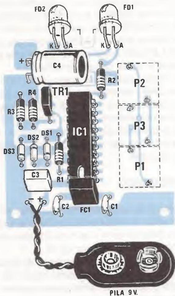
Fig.27 In questa foto potrete facilmente intravedere i tre pulsanti di comando (P1 - P2 - P3), montati sul lato opposto di tale stampato. Ricordate di porre in posizione verticale il condensatore elettrolitico C4, se desiderate racchiuderlo entro il mobiletto plastico che forniamo assieme al kit (vedi figg.29-30).
