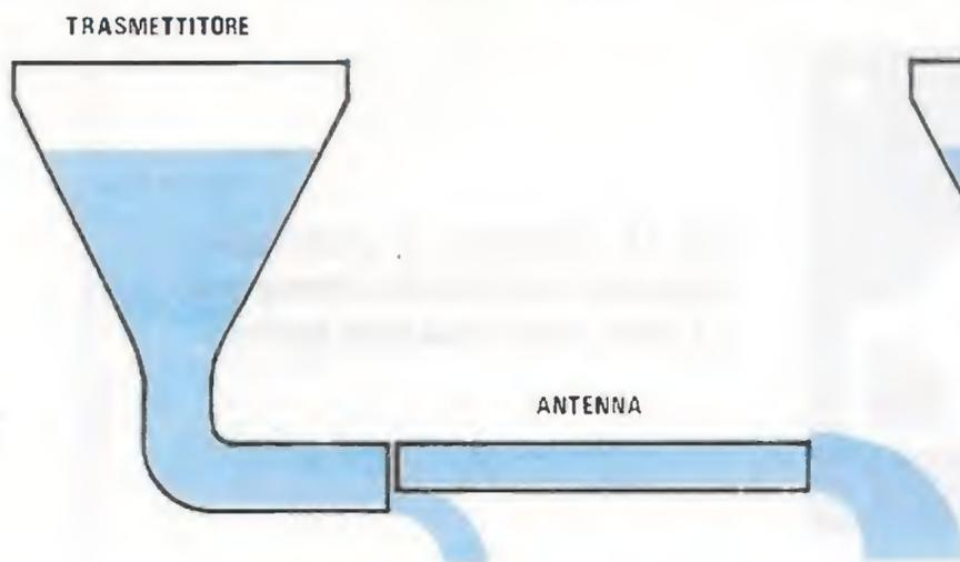
Fig.9 Vale a dire che se l'impedenza di uscita di un trasmettitore è minore (vedi fig.8) o maggiore rispetto a quella dell'antenna, si verificerebbero le stesse perdite che si producono in idraulica congiungendo insieme due tubi di diverso diametro.
