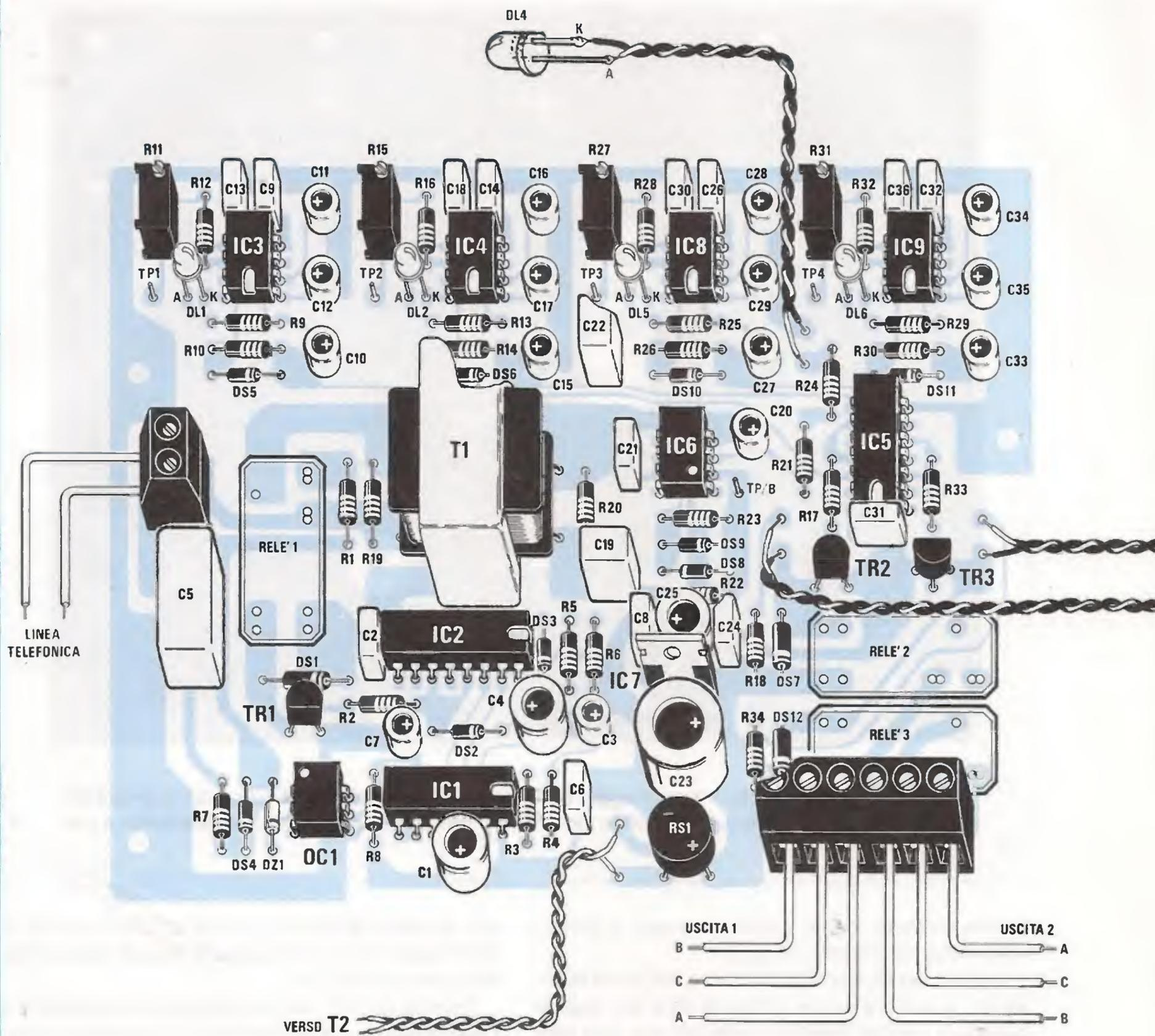
Fig.7 Schema pratico di montaggio dello stadio ricevente, e a destra tutte le connessioni degli integrati visti da sopra e dei soli transistor visti da sotto. Nota: se nella vostra linea telefonica sono presenti tre fili, controllando attentamente scoprirete che solo "due" portano il segnale di BF. Il terzo filo risulta quasi sempre cortocircuitato con uno degli altri due.
