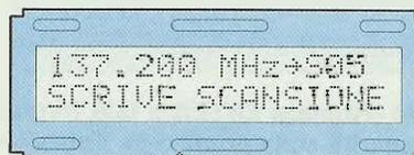
**Fig.39** Se la frequenza da modificare fosse di tipo "S", dovrete far apparire la scritta **Scrive Scansione**. Premendo **ENTER** la frequenza S05 verrà sostituita da quella che appare sul display.
