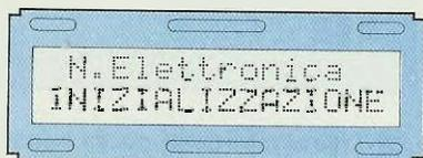
Fig. 29 Per automemorizzare le frequenze di tutti i satelliti, dovrete tener premuto ENTER e poi accendere il ricevitore.
