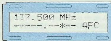
Fig.28 Premendo contemporaneamente i tasti FUNZ/ENTER, sulla seconda riga vi apparirà l'asterisco dell'AFC.
