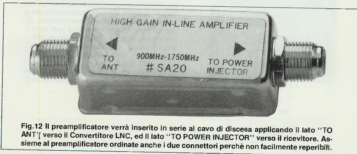
Fig.12 Il preamplificatore verrà inserito in serie al cavo di discesa applicando il lato "TO ANT" verso il Convertitore LNC, ed il lato "TO POWER INJECTOR" verso il ricevitore. Assieme al preamplificatore ordinate anche i due connettori perchè non facilmente reperibili.
