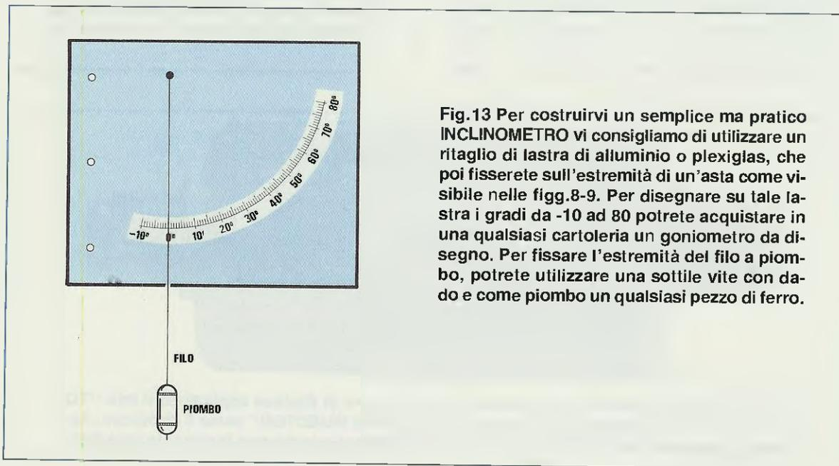
Fig.13 Per costruirvi un semplice ma pratico **INCLINOMETRO** vi consigliamo di utilizzare un ritaglio di lastra di alluminio o plexiglas, che poi fisserete sull'estremità di un'asta come visibile nelle figg.8-9. Per disegnare su tale lastra i gradi da -10 ad 80 potrete acquistare in una qualsiasi cartoleria un goniometro da disegno. Per fissare l'estremità del filo a piombo, potrete utilizzare una sottile vite con dado e come piombo un qualsiasi pezzo di ferro.
