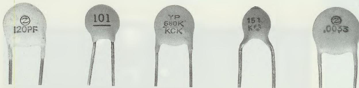
Fig.1 Decifrare il primo condensatore ceramico non sarà difficoltoso, poichè tutti leggeranno 120 pF, mentre per il secondo siglato 101 la capacità è di 100 pF. Il terzo siglato 680K è da 680 pF perchè K significa Keramico (ceramico). Il quarto siglato 151 è da 150 pF, mentre per quello di destra siglato 2A273K non si dovrà leggere nè 2A nè K, quindi rimane 27 + 000, cioè 27.000 pF.
