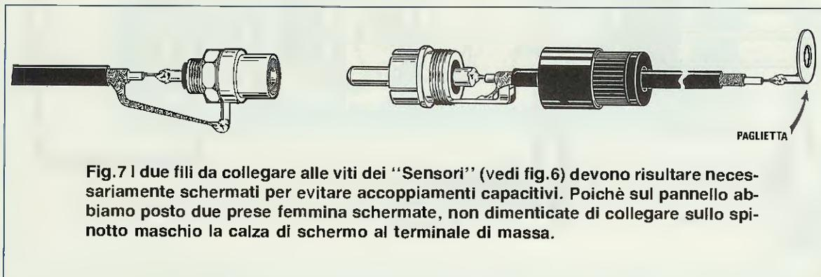
Fig. 7 I due fili da collegare alle viti dei "Sensori" (vedi fig. 6) devono risultare necessariamente schermati per evitare accoppiamenti capacitivi. Poichè sul pannello abbiamo posto due prese femmina schermate, non dimenticate di collegare sullo spinnotto maschio la calza di schermo al terminale di massa.
