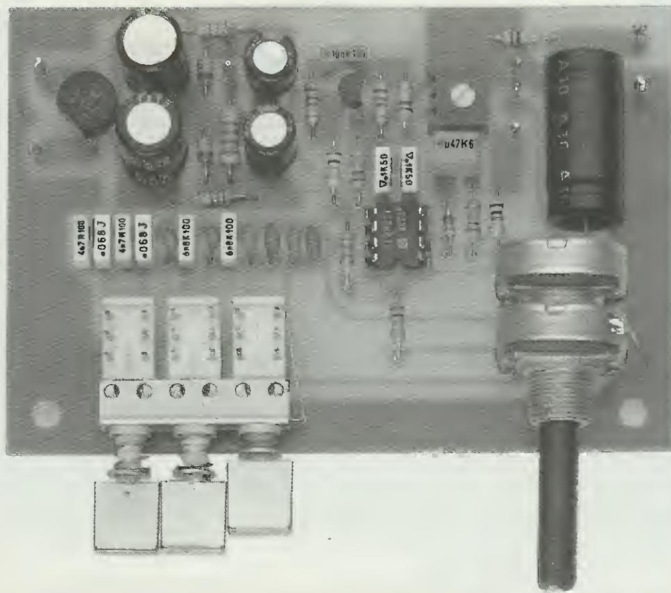
Fig.5 In questa foto potete vedere un Generatore di BF che abbiamo fatto montare ad un giovane studente per verificare quali difficoltà avrebbe incontrato. Il circuito ha funzionato subito, anche se pur avendo letto l'articolo questo giovane ha erroneamente rivolto il "trafilato di alluminio" del commutatore a slitta in alto anzichè in basso (vedi fig.6).
