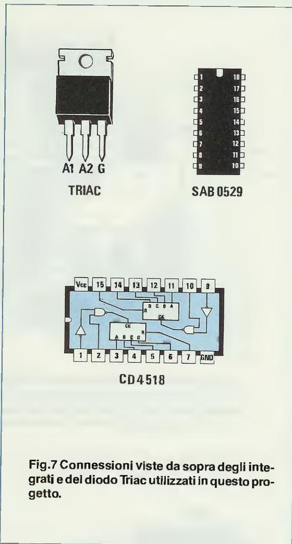
Fig.7 Connessioni viste da sopra degli integrati e del diodo Triac utilizzati in questo progetto.
