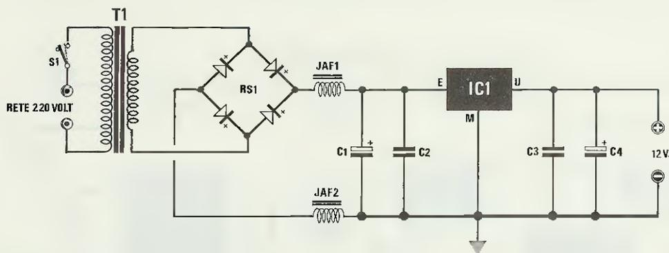
Fig.6 Schema elettrico dello stadio di alimentazione LX.997.
