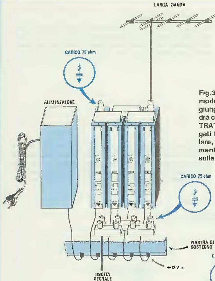
Fig.334 Utilizzando degli amplificatori modello "C", se da un'unica direzione giungono 4 emittenti forti, l'antenna andrà collegata ad una delle due prese ENTRATA. Tutti i moduli andranno collegati tra loro con il cavalletto rettangolare, innestando la banana del filo di alimentazione nelle BOCCOLE presenti sulla piastra di sostegno.
