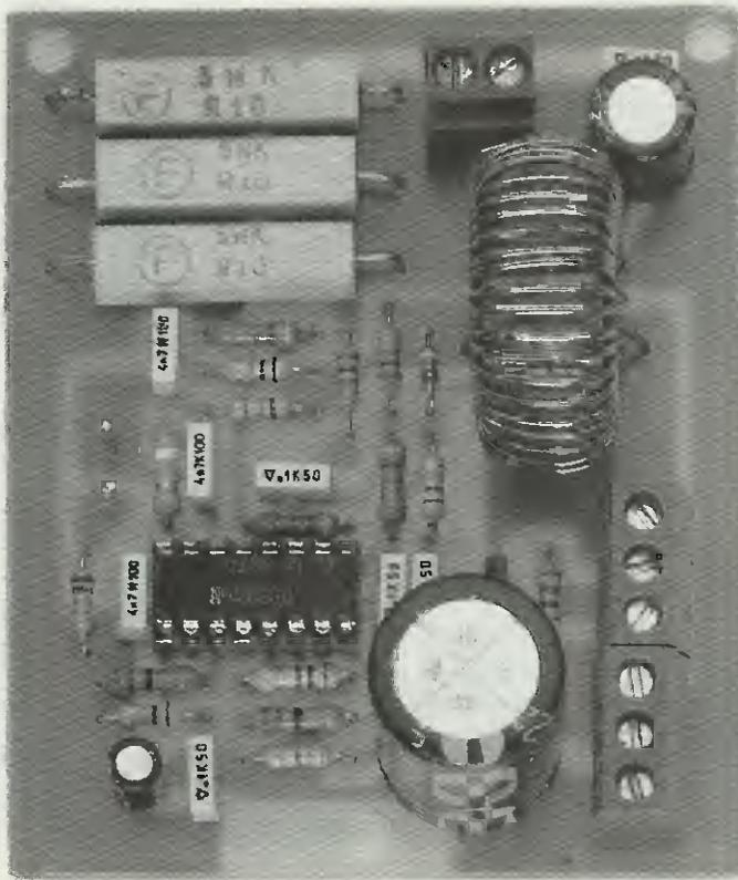
Fig.6 Foto ingrandita della scheda LX.979. Consigliamo di tenere le tre resistenze a filo R18-R19-R20 sollevate di 1-2 mm. rispetto allo stampato. Poichè in questa foto molti leggeranno R10 = 10 ohm, facciamo presente che la R equivale ad un VIRGOLA quindi: "10 ohm = 0,10" ohm.
