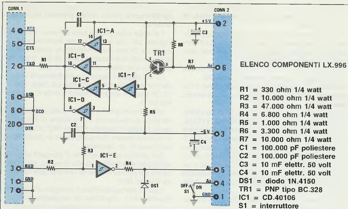
**Fig.20** Schema elettrico dello stadio LX.996 necessario per trasferire via porta "seriale" una immagine congelata direttamente su un computer IBM compatibile. Questa scheda risulterà molto utile ai RADIOAMATORI per trasmettere immagini via radio-fax.
