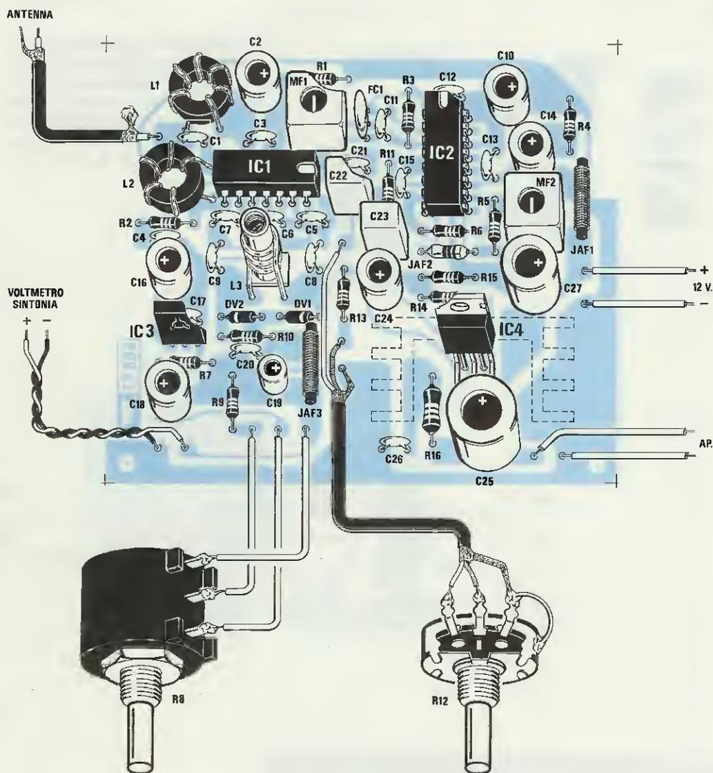
Fig.9 Schema pratico di montaggio del ricevitore in FM. Il filo da avvolgere all'interno dei due nuclei toroidali L1-L2 deve risultare smaltato per evitare che le spire entrino in contatto con il rame posto sul lato superiore dello stampato (vedi foto di lato). Ai due fili indicati "Voltmetro Sintonia" potrete collegare il circuito di fig.12, a quelli indicati "AP" l'altoparlante ed a quelli indicati "12 V" la tensione di alimentazione.
