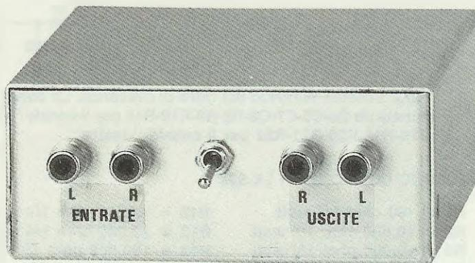
Un filtro di presenza è un circuito elettronico che permette di modificare la linearità della banda passante di un amplificatore nella zona dello spettro sonoro della gamma dei toni medi, esaltando così tutte le frequenze caratteristiche della voce umana.
