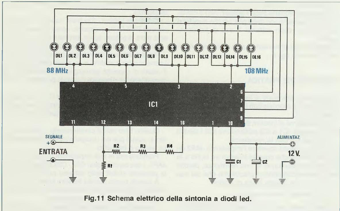
Fig.11 Schema elettrico della sintonia a diodi led.
