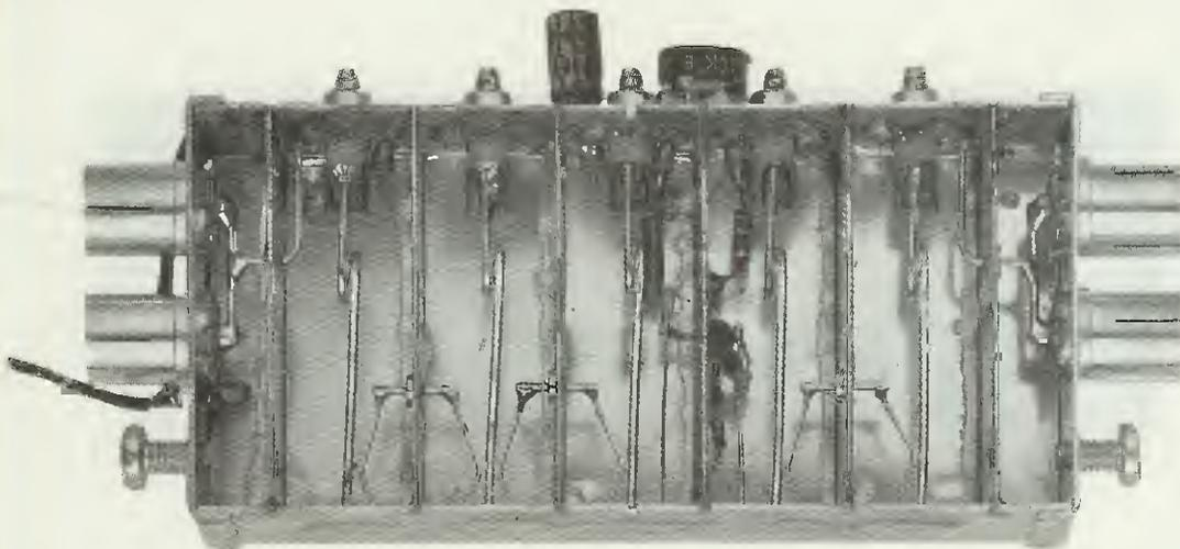
**Fig.323** Un amplificatore monocanale modello "C" provvisto del solo filo per l'ingresso dei 12 volt (vedi fig.317). Anche in questo modello le due prese di ENTRATA e di USCITA sono collegate in parallelo con uno spezzone di filo di rame.
