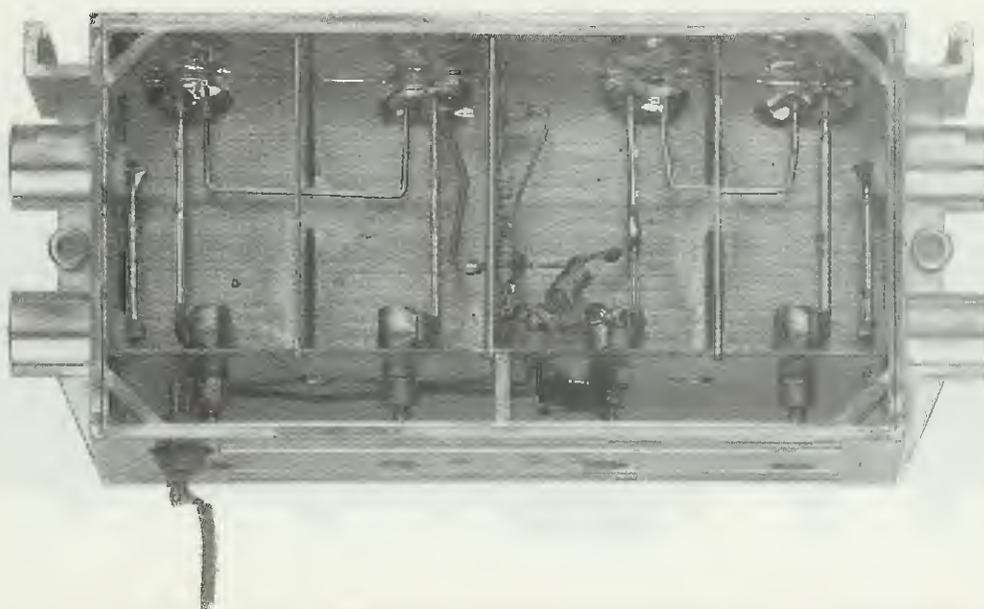
**Fig.322** Un amplificatore monocanale modello "B" provvisto di filo con banana e di boccia separata per i 12 volt. Come potrete notare, le due prese di ENTRATA e quelle di USCITA sono collegate in parallelo con un corto spezzone di filo di rame.
