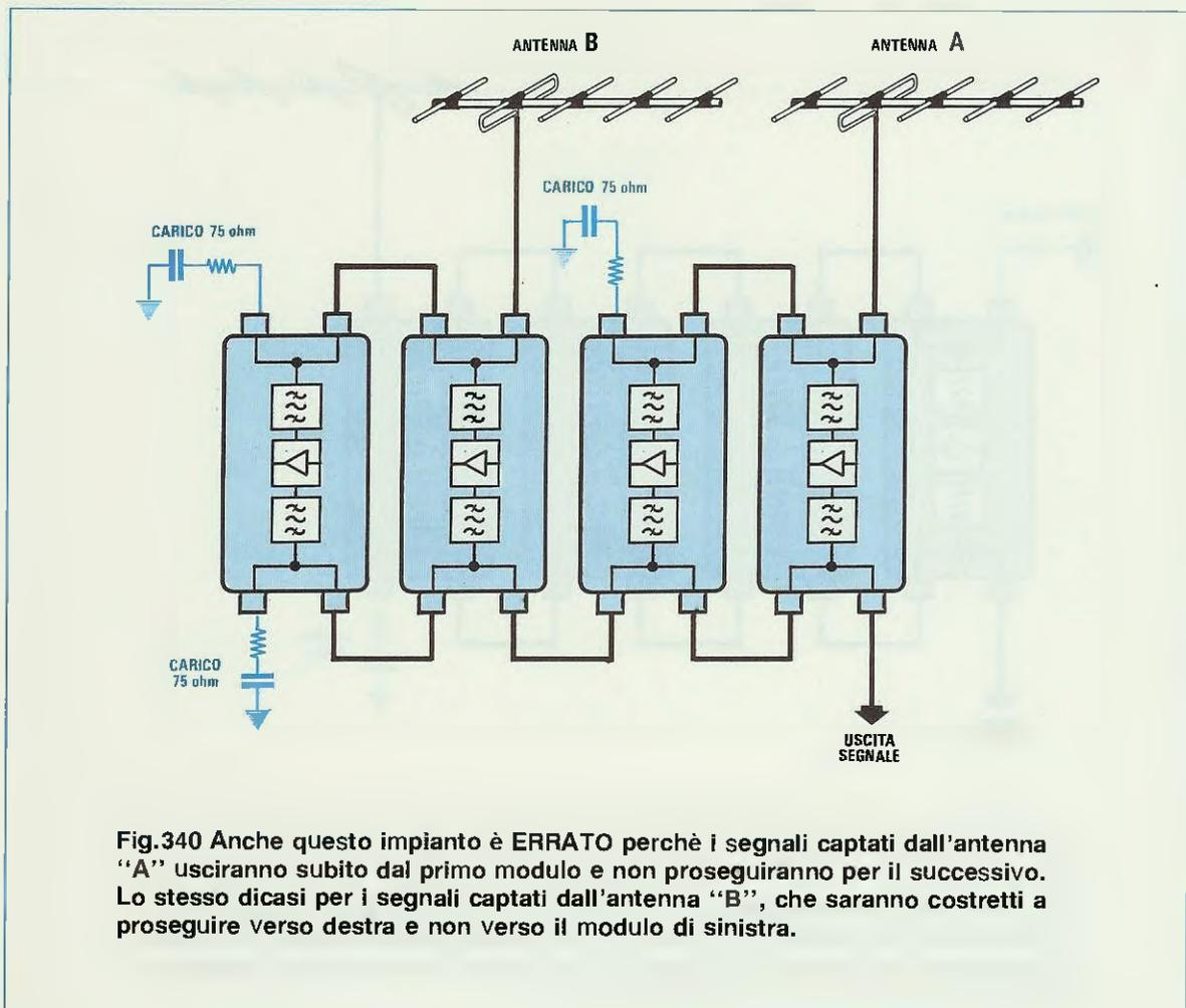
**Fig.340** Anche questo impianto è **ERRATO** perchè i segnali captati dall'antenna "A" usciranno subito dal primo modulo e non proseguiranno per il successivo. Lo stesso dicasi per i segnali captati dall'antenna "B", che saranno costretti a proseguire verso destra e non verso il modulo di sinistra.
