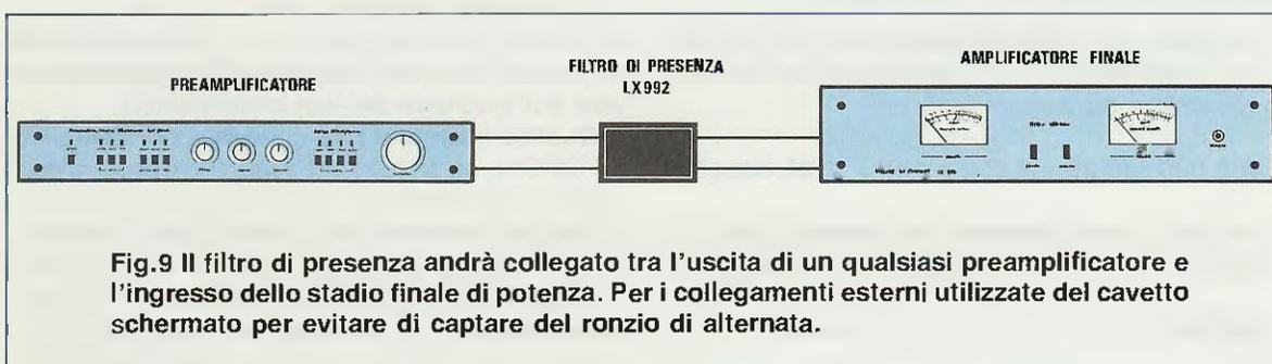
**Fig.9 Il filtro di presenza andrà collegato tra l'uscita di un qualsiasi preamplificatore e l'ingresso dello stadio finale di potenza. Per i collegamenti esterni utilizzate del cavetto schermato per evitare di captare del ronzio di alternata.**
