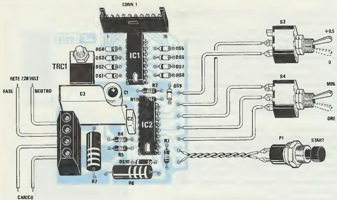
Fig.5 Schema pratico di montaggio dello stampato LX.974. Nel primo polo della morsettieria posta sulla sinistra dello stampato, inserite il filo NEUTRO dei 220 volt e nel secondo polo il filo di FASE. Agli ultimi due poli (vedi Carico) collegherete l'apparecchio o il circuito che desidererete temporizzare.
