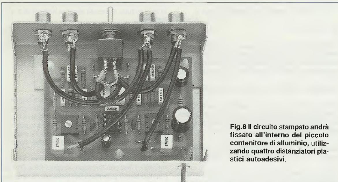
**Fig.8 Il circuito stampato andrà fissato all'interno del piccolo contenitore di alluminio, utilizzando quattro distanziatori plastici autoadesivi.**
