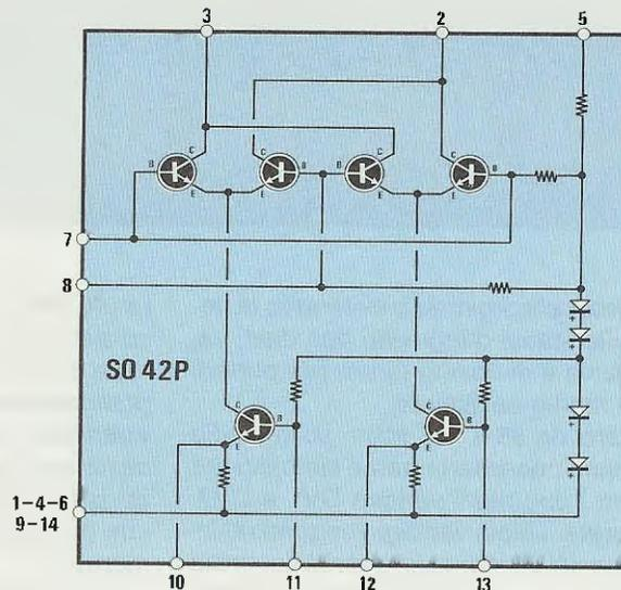
Fig.3 Schema elettrico interno dell'integrato oscillatore/miscelatore SO.42P.
