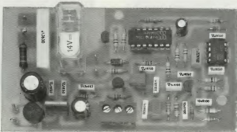
Fig.9 A montaggio ultimato, il vostro stadio ricevente dovrà presentarsi simile a quello visibile in questa foto. La morsetteria a tre poli collocata sullo stampato dovrà essere utilizzata per stringere i due terminali della capsula ricevente dopo aver fissato lo stampato entro il mobile.
