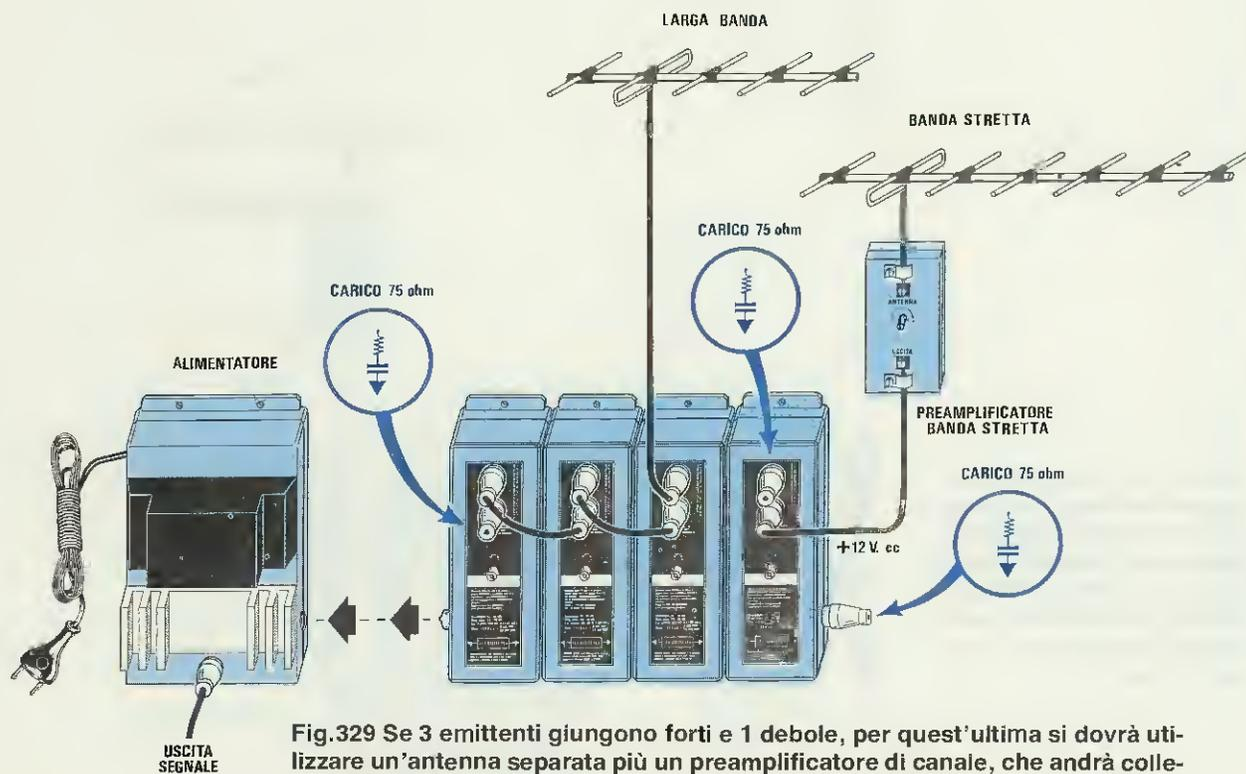
Fig.329 Se 3 emittenti giungono forti e 1 debole, per quest'ultima si dovrà utilizzare un'antenna separata più un preamplificatore di canale, che andrà collegato alla presa ENTRATA +12 V chiudendo l'altro ingresso con una resistenza di carico. Per le altre 3 emittenti, il cavo di discesa andrà collegato alla normale presa ENTRATA.
