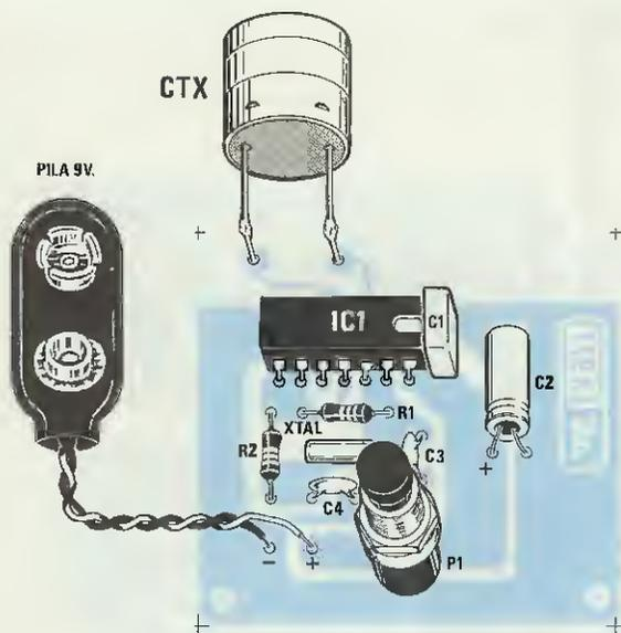
Fig.5 Schema pratico di montaggio dello stadio trasmettente. I terminali del pulsante P1 sono direttamente saldati sulle piste in rame dello stampato. Vi ricordiamo ancora che la capsula trasmittente (vedi CTX) è quella siglata MA.40B5/S.
