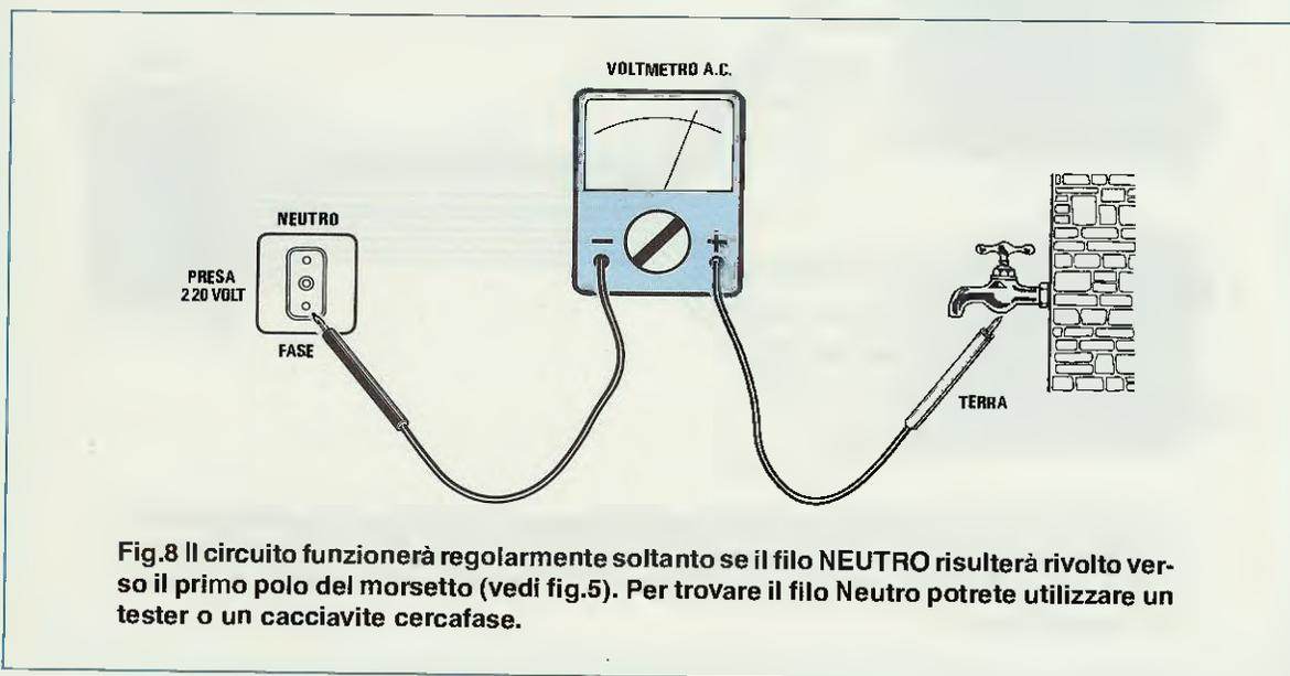
Fig.8 Il circuito funzionerà regolarmente soltanto se il filo NEUTRO risulterà rivolto verso il primo polo del morsetto (vedi fig.5). Per trovare il filo Neutro potrete utilizzare un tester o un cacciavite cercafase.
