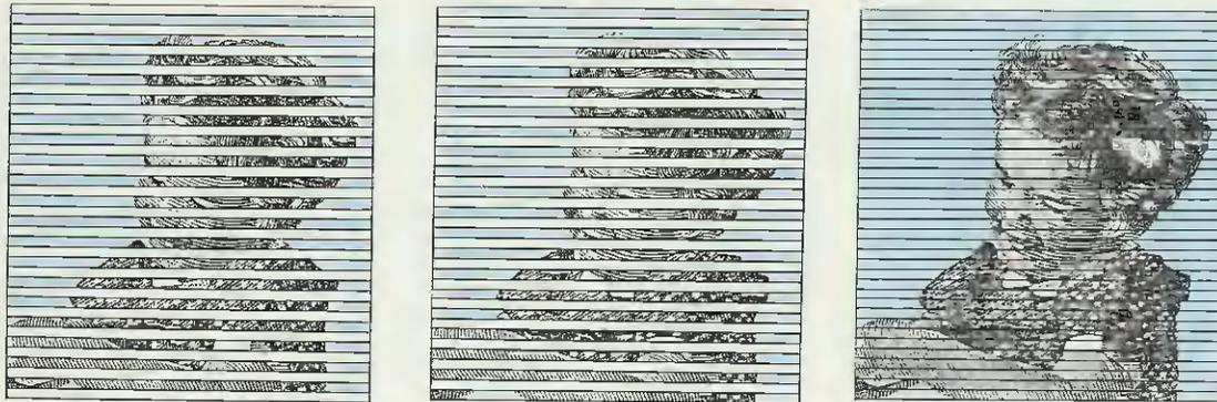
Fig.9 Per evitare lo sfarfallio, ogni immagine viene riprodotta sullo schermo di una TV con due quadri, uno composto da sole righe pari ed uno da sole righe dispari. Interacciando questi due quadri, il nostro occhio per effetto della persistenza ottica caratteristica della retina vedrà un'immagine completa.
