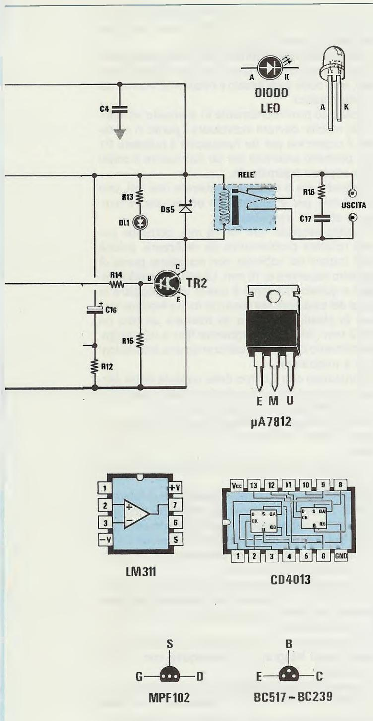
**Fig.2** Schema elettrico dello stadio ricevente e connessioni degli integrati visti da sopra e del fet e transistor visti da sotto. Come si noterà, la capsula ricevente presenta a fine sigla la lettera "R" (Receive) MA.40B5/R.
