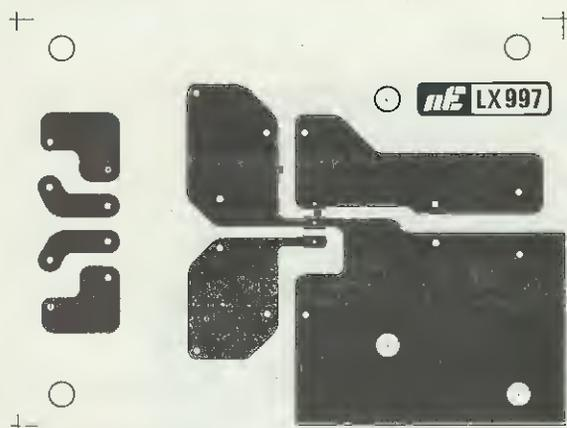
Fig.7 Disegno a grandezza naturale dello stampato LX.997 visto dal lato rame. Sostituendo l'integrato ed il trasformatore di alimentazione potrete utilizzare questo stampato anche per realizzare alimentatori da 5-8-15-18-24 volt.
