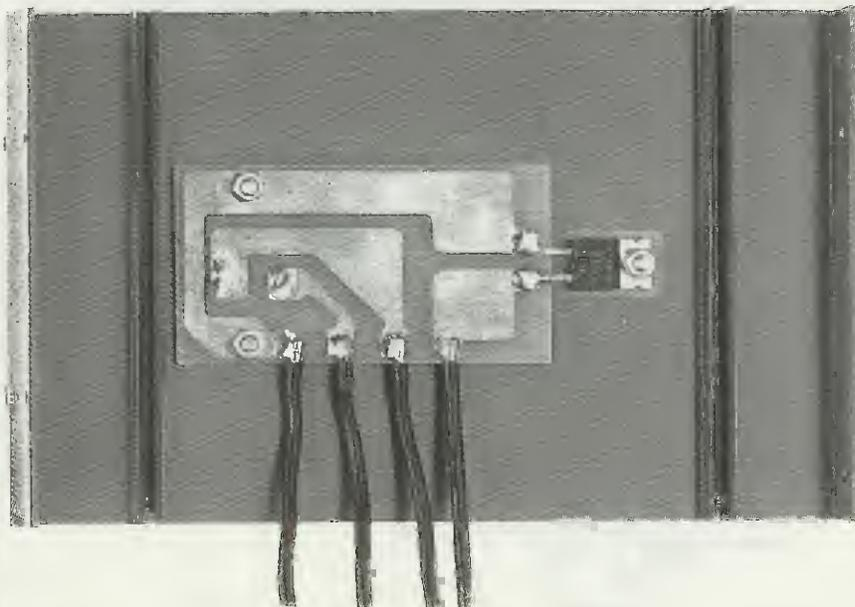
**Fig.5** Sull'aletta di raffreddamento posta lateralmente sul mobile, dovrete fissare il transistor TR1 (vedi fig.7) e sopra a questo lo stampato LX.979/B ed il diodo DS1. Non dimenticatevi di interporre una MICA isolante tra il corpo di TR1-DS1 e l'aletta.
