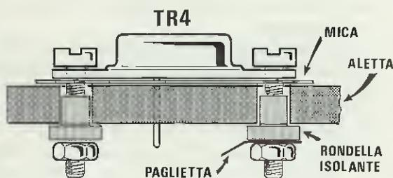
**Fig.4** Il transistor di BUW.32 fissato sopra l'aletta di raffreddamento posta nel mobile (vedi fig.9), andrà isolato con la mica e le rondelle isolanti fornite assieme al kit.
