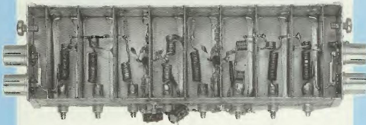
**Fig.324** Nella lista delle caratteristiche che dovrebbe trovarsi sempre allegata ai vari modelli di amplificatori monocanale, dovrete controllare i dB di amplificazione, il numero dei transistor o mosfet utilizzati, la cifra di rumore e la selettività. Un amplificatore può essere composto da molte più celle e compensatori di taratura.
