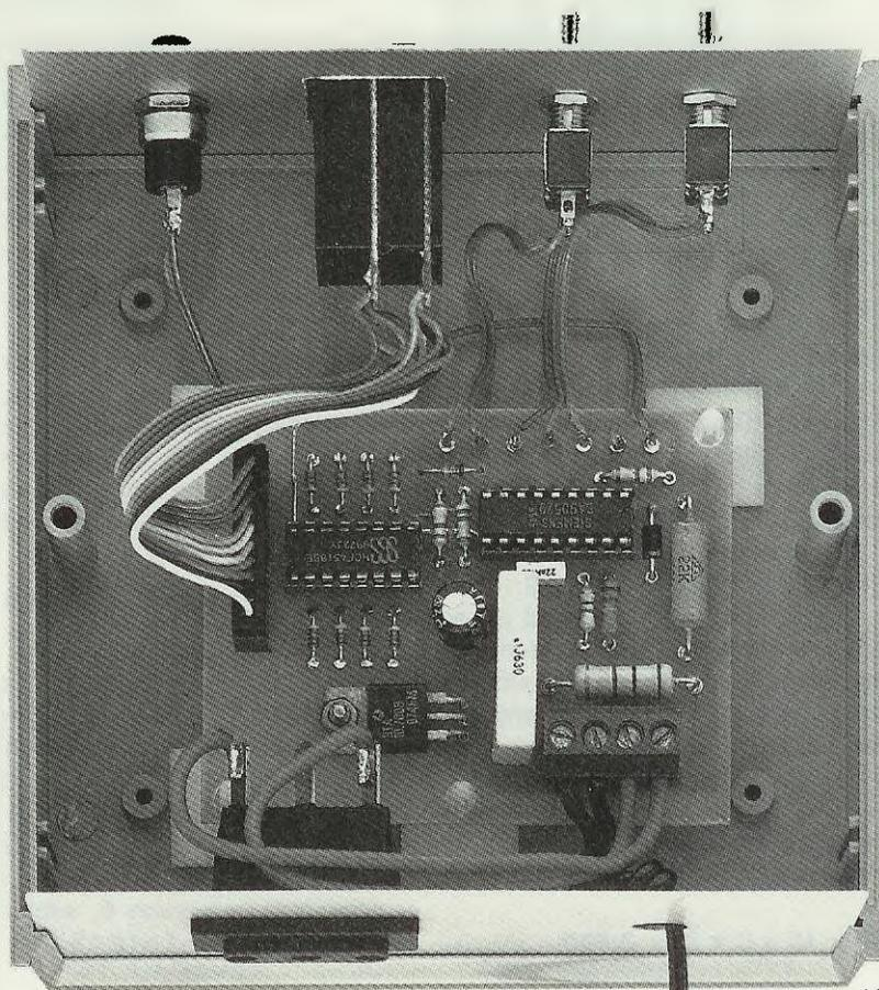
Fig.1 Foto dell'interno del mobile. Sul pannello posteriore fisserete una presa femmina dei 220 volt, mentre sul pannello frontale il doppio commutatore digitale, i due deviatori ed il pulsante di Start (vedi foto a sinistra).
