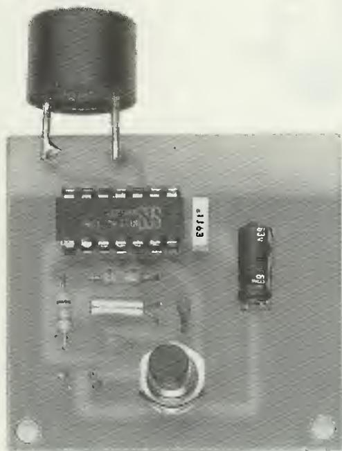
Fig.6 Foto notevolmente ingrandita dello stadio trasmettente. Al centro dello stampato, poco sopra al pulsante P1, noterete il piccolo quarzo cilindrico collocato in posizione orizzontale.
