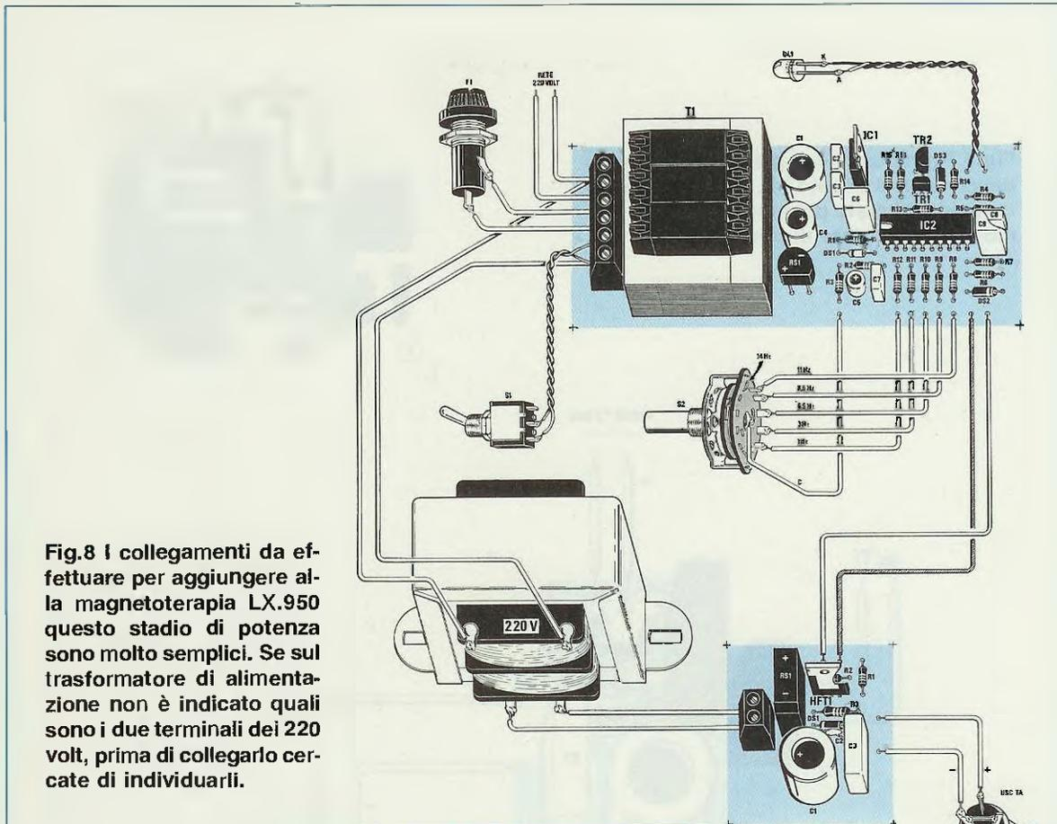
Fig.8 I collegamenti da effettuare per aggiungere alla magnetoterapia LX.950 questo stadio di potenza sono molto semplici. Se sul trasformatore di alimentazione non è indicato quali sono i due terminali dei 220 volt, prima di collegarlo cercate di individuarli.
