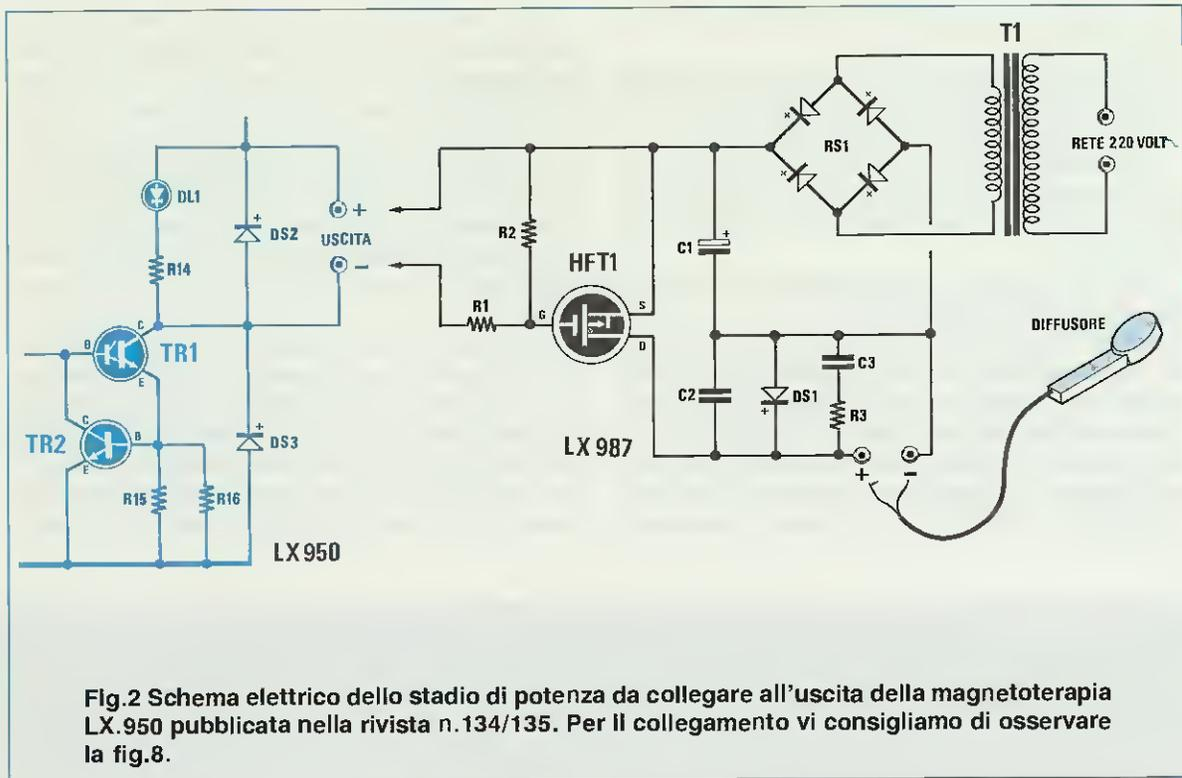
Fig.2 Schema elettrico dello stadio di potenza da collegare all'uscita della magnetoterapia LX.950 pubblicata nella rivista n.134/135. Per il collegamento vi consigliamo di osservare la fig.8.
