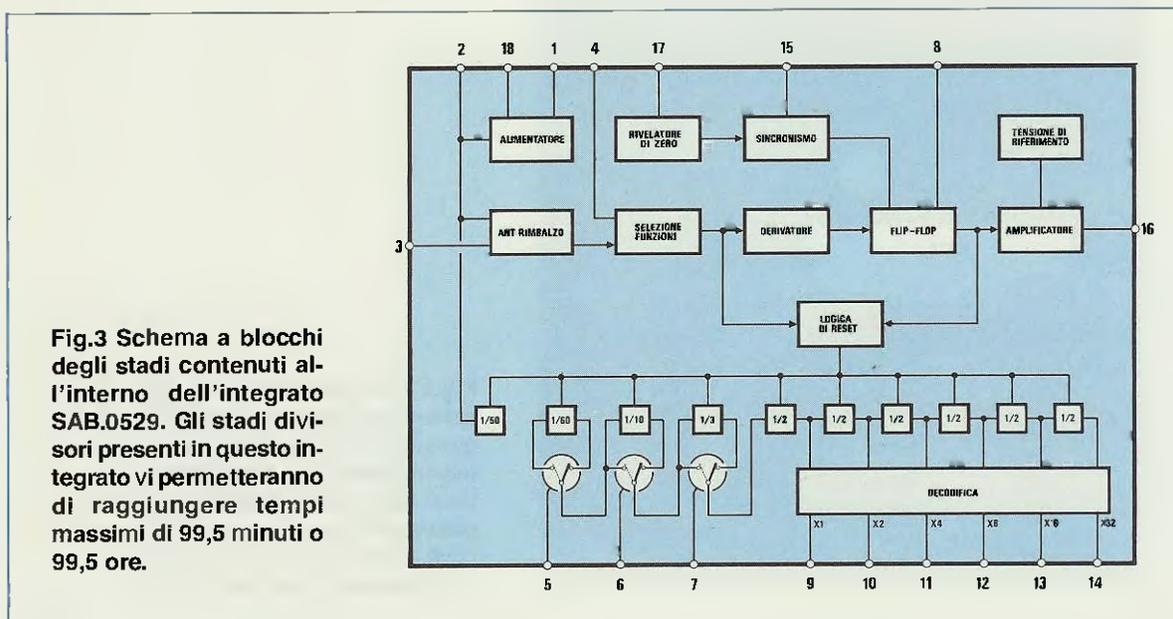
Fig.3 Schema a blocchi degli stadi contenuti all'interno dell'integrato SAB.0529. Gli stadi divisori presenti in questo integrato vi permetteranno di raggiungere tempi massimi di 99,5 minuti o 99,5 ore.
