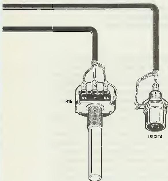
Fig.6 Schema pratico di montaggio del Generatore di BF. Non dimenticatevi di collegare a massa le carcasse metalliche dei due potenziometri R10 e R15. In questo disegno si noterà anche che il "trafilato di alluminio" del commutatore a slitta è rivolto verso lo stampo e non alla rovescia come visibile nella foto di fig.5.
