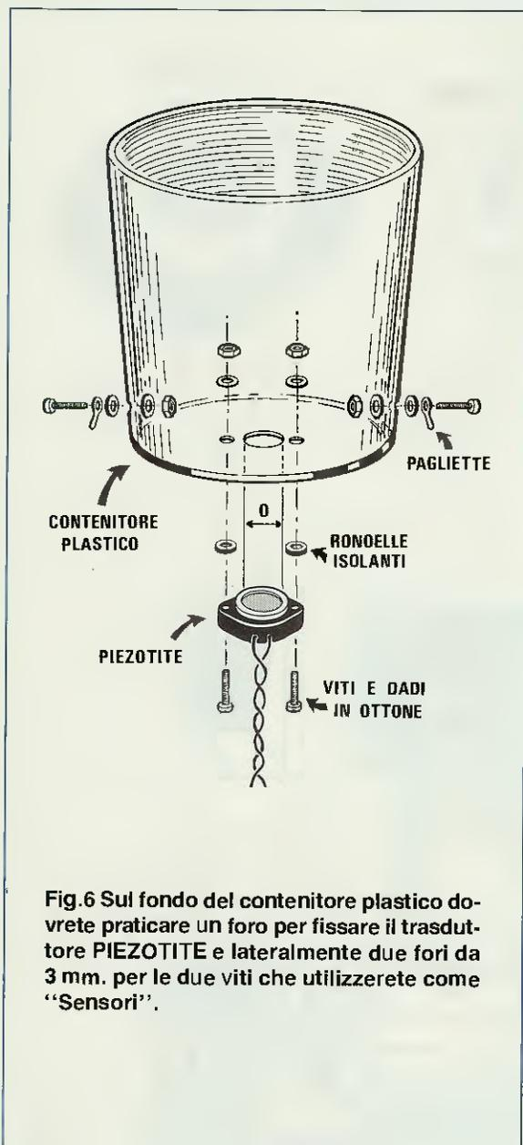
Fig. 6 Sul fondo del contenitore plastico dovrete praticare un foro per fissare il trasduttore PIEZOTITE e lateralmente due fori da 3 mm. per le due viti che utilizzerete come "Sensori".
