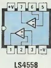
Fig.4 Connessioni dell'integrato LS.4558, visto da sopra, utilizzato per questo filtro di presenza. Si noti a sinistra la "tacca" di riferimento.
