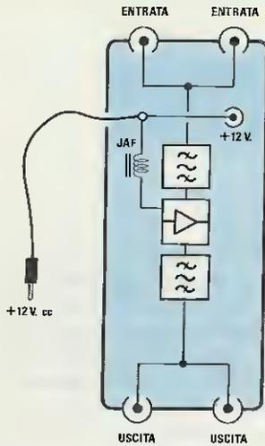
Fig.332 Guardando lo schema interno degli amplificatori modello "B" potrete subito comprendere perchè il filo completo di banana vada innestato nel modulo successivo e quello dell'ultimo modulo di sinistra nel modulo di alimentazione.
