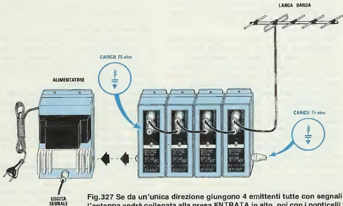
Fig.327 Se da un'unica direzione giungono 4 emittenti tutte con segnali forti, l'antenna andrà collegata alla presa ENTRATA in alto, poi con i ponticelli forniti dalla Casa andranno collegate le Entrate degli altri moduli come visibile in figura. Nell'ultimo modulo si innesterà l'alimentatore e nelle prese Entrata e Uscita libere un carico resistivo provvisto internamente di CONDENSATORE.
