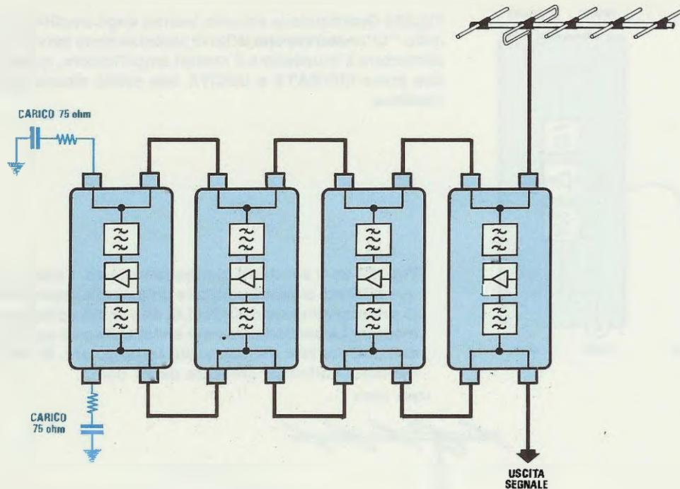
**Fig.338** Anche se tutte le ENTRATE e le USCITE sono collegate tra loro, NON è consigliabile prelevare i segnali miscelati dall'uscita del modulo al quale risulta collegata l'antenna. Il montaggio visibile in figura è ERRATO, pertanto andrà modificato con lo schema corretto di fig.339.
