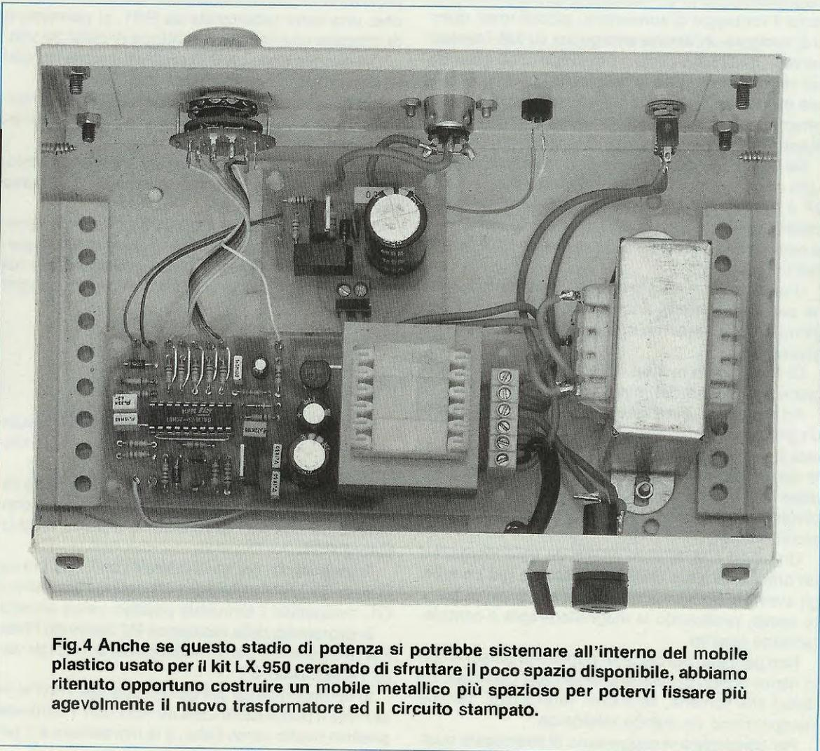
**Fig.4** Anche se questo stadio di potenza si potrebbe sistemare all'interno del mobile plastico usato per il kit LX.950 cercando di sfruttare il poco spazio disponibile, abbiamo ritenuto opportuno costruire un mobile metallico più spazioso per potervi fissare più agevolmente il nuovo trasformatore ed il circuito stampato.
