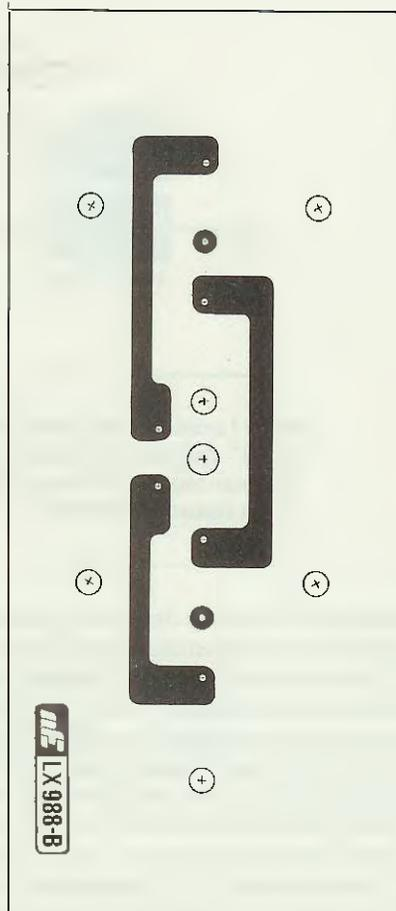
Fig.6 Disegno a grandezza naturale del circuito stampato LX.988/B necessario per sostenere le due cicline (vedi foto in basso).
