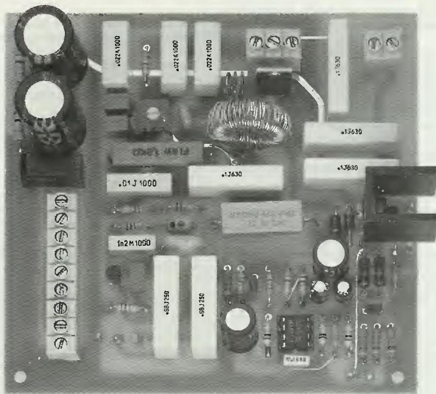
**Fig.3** Prima di pubblicare qualsiasi progetto, è nostra consuetudine montarne più esemplari per le prove di collaudo. Tali montaggi si riconoscono nelle foto perchè sul circuito stampato le piste in rame appaiono ancora prive di vernice protettiva e perchè è assente il disegno serigrafico dei componenti. In questo caso, si possono notare la bobina L1 (posta dietro alla JAF5) e l'aletta di raffreddamento fissata sul transistor TR3.
