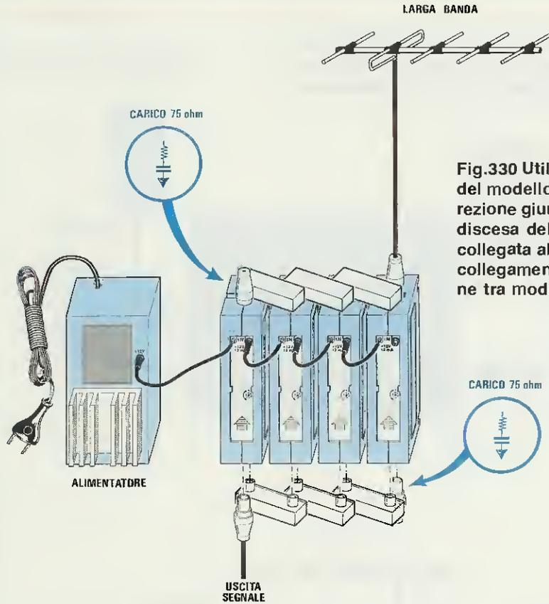
Fig.330 Utilizzando un amplificatore del modello "B", se dalla stessa direzione giungono 4 emittenti forti, la discesa dell'antenna andrà sempre collegata al primo modulo. Si noti il collegamento del filo di alimentazione tra modulo e modulo.
