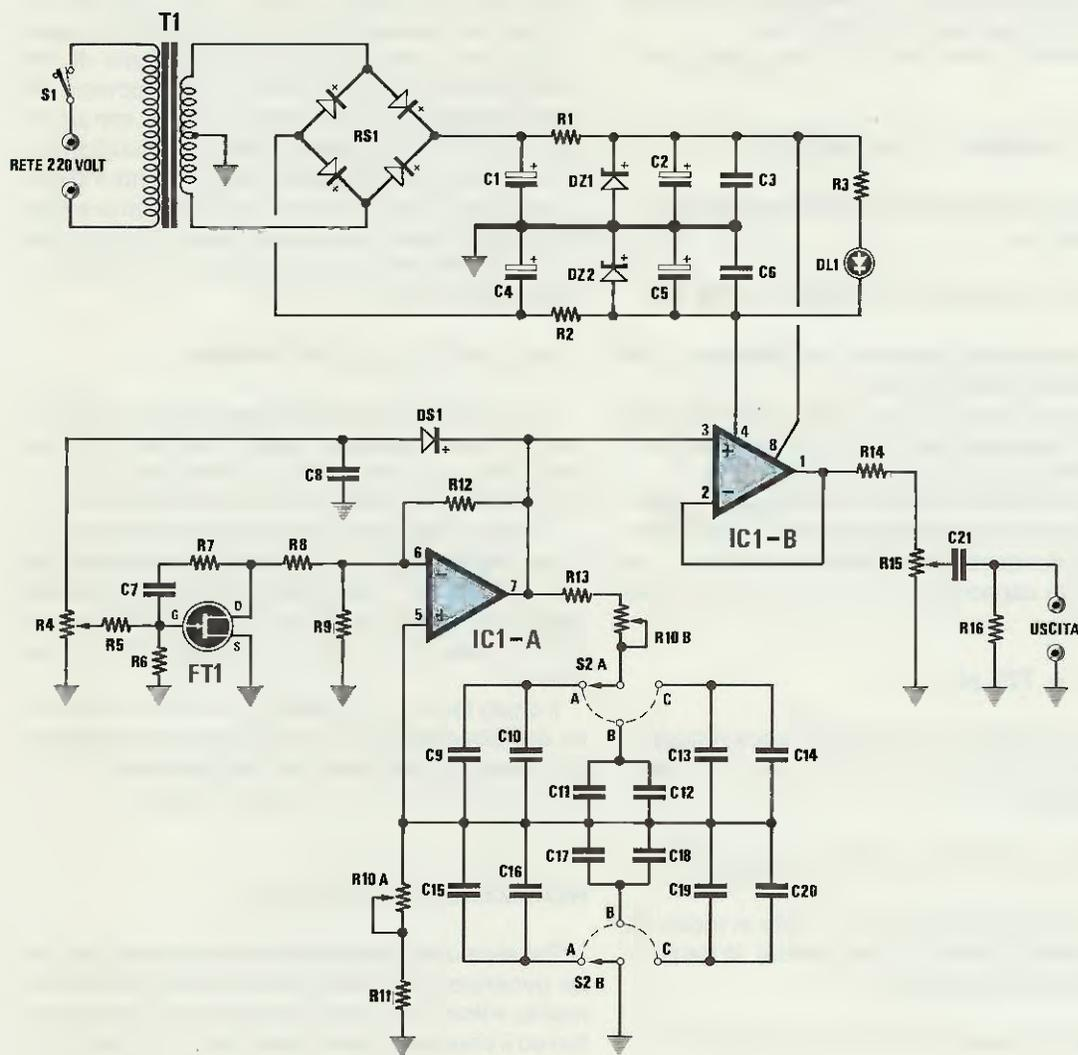
Fig.1 Schema elettrico del generatore di segnali sinusoidali di BF e connessioni dell'integrato TL082 visto da sopra e del fet MPF.102 visto da sotto, cioè dal lato in cui i terminali fuoriescono dal corpo. NOTA: Il commutatore S2/A-S2/B lo abbiamo disegnato "rotativo" solo per rendere più comprensibile lo schema; in realtà tale commutatore è a slitta (vedi fig.6).
