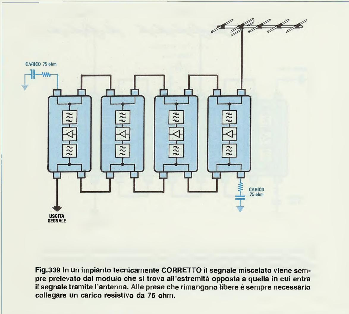
**Fig.339** In un impianto tecnicamente **CORRETTO** il segnale miscelato viene sempre prelevato dal modulo che si trova all'estremità opposta a quella in cui entra il segnale tramite l'antenna. Alle prese che rimangono libere è sempre necessario collegare un carico resistivo da 75 ohm.
