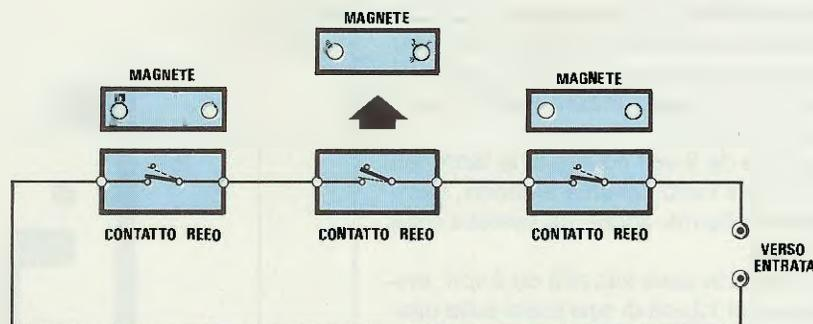
**Fig.7 I contatti magnetici da utilizzare per questo antifurto debbono “chiudersi” quando viene appoggiato il magnete ed “aprirsi” quando viene allontanato. Tutti i contatti, come potete vedere in questo disegno, devono essere collegati in serie.**
