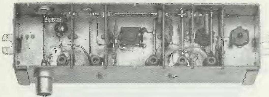
**Fig.321** Osservando internamente questi amplificatori monocanale, si noterebbe subito una notevole differenza tra le diverse Case Costruttrici. In questo modello tipo "A" potete vedere sulla presa ENTRATA +12 e sulle due USCITE le impedenze di blocco per AF avvolte su ferrite.
