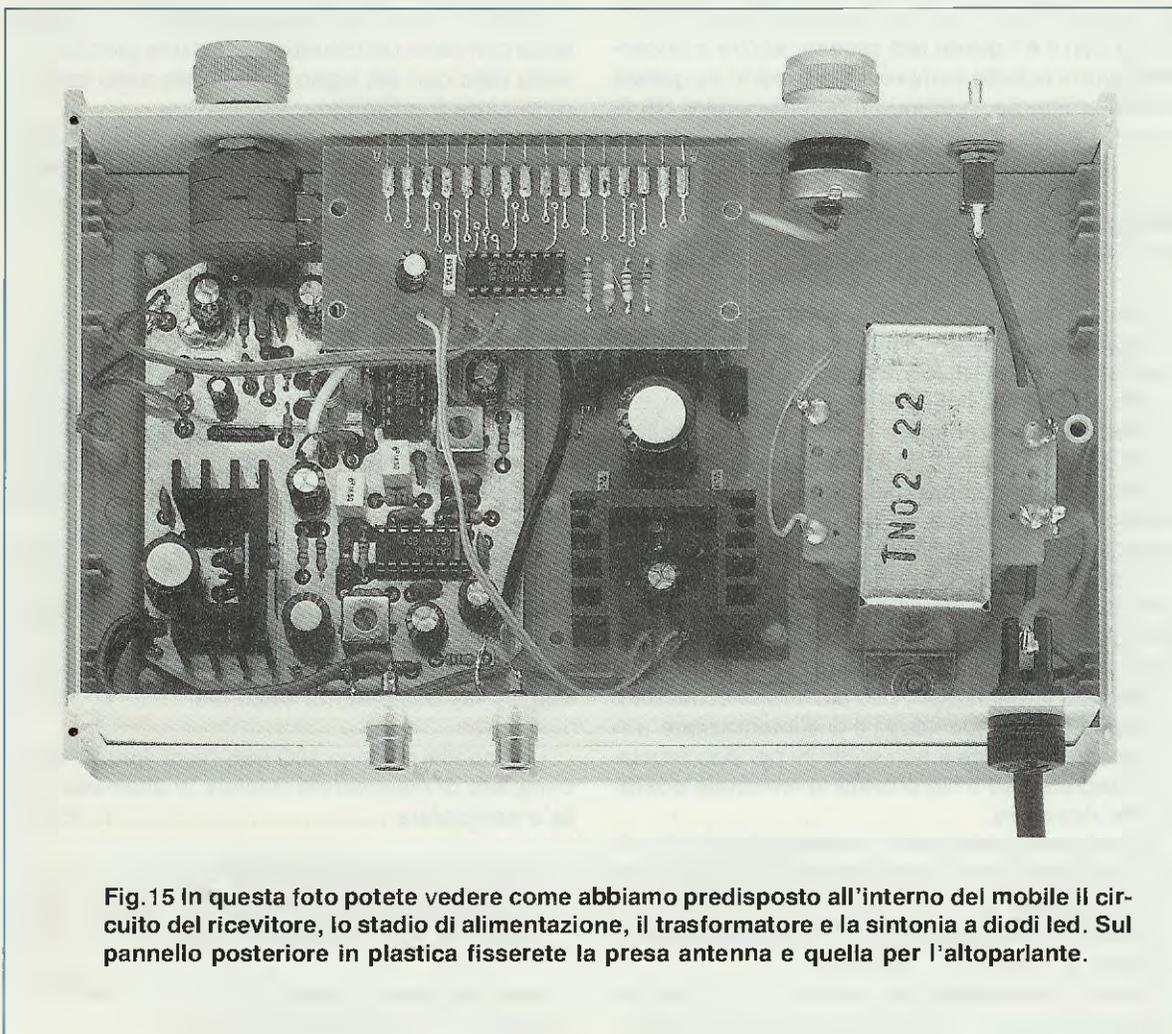
Fig. 15 In questa foto potete vedere come abbiamo predisposto all'interno del mobile il circuito del ricevitore, lo stadio di alimentazione, il trasformatore e la sintonia a diodi led. Sul pannello posteriore in plastica fisserete la presa antenna e quella per l'altoparlante.
