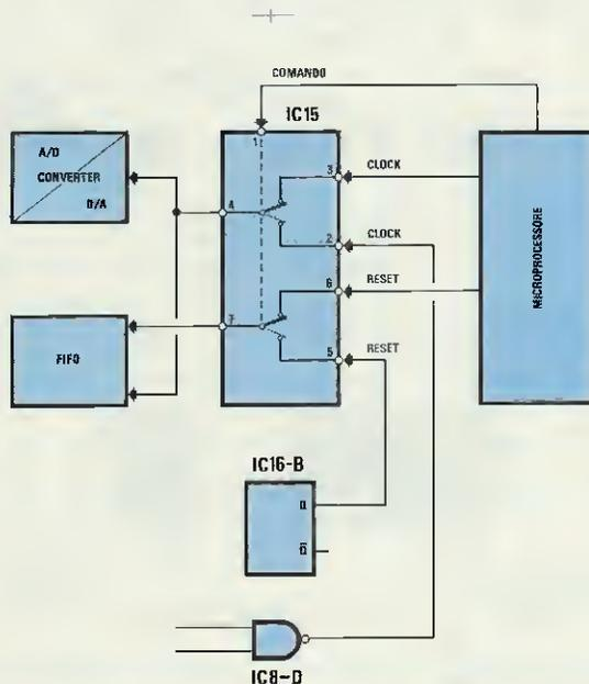
Fig.16 Ogniqualevolta premerete il pulsante MEMORY per congelare l'immagine da stampare o da inviare ad un computer, l'integrato IC15 (vedi fig.17) utilizzato come doppio deviatore elettronico preleverà i segnali di Clock e Reset dal microprocessore, anzichè dagli integrati IC16/B e IC8/D.
