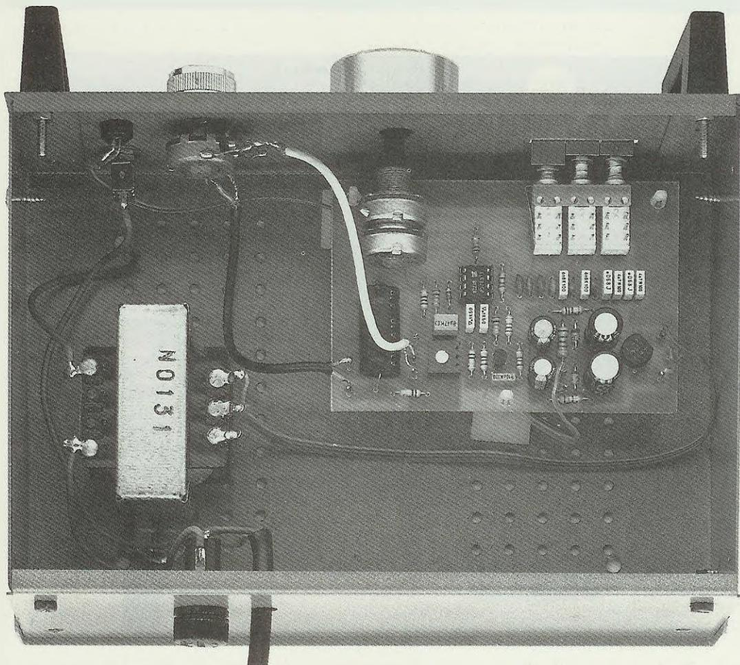
**Fig.7 All'interno del mobile metallico completo di mascherina forata e serigrafata (vedi foto all'inizio dell'articolo) fisserete il trasformatore di alimentazione e il circuito stampato, controllando che i tasti del commutatore scorrano senza attrito nelle asole del pannello frontale.**
