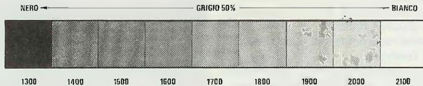
**Fig. 2** Tutte le TELEFOTO trasmesse sulle onde lunghe utilizzano una diversa frequenza per riprodurre le tonalità di grigio, partendo da un livello di nero per terminare con un livello di bianco. Una frequenza di 1.300 Hz corrisponde ad un tratto NERO, una frequenza di 2.100 Hz corrisponde ad un tratto BIANCO. Qualsiasi altra frequenza compresa tra questi due valori corrisponde ad una diversa tonalità di GRIGIO.
