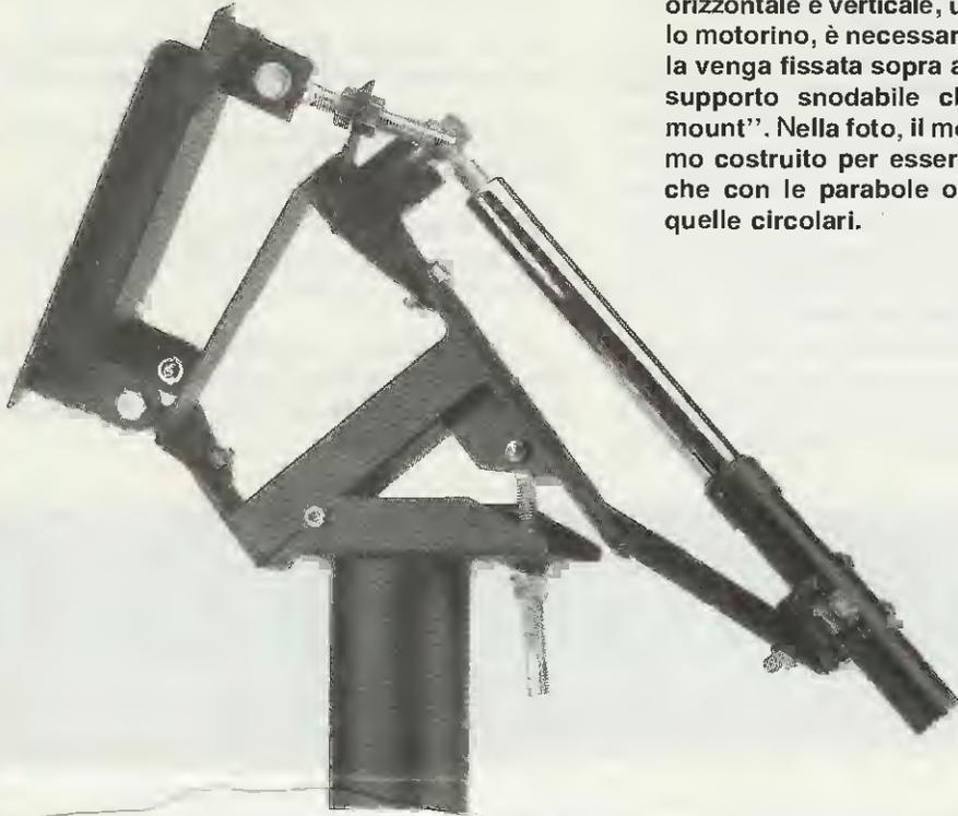
**Fig.2** In tutti i tipi di Polarmount troverete due viti di regolazione (vedi A e B), che dovranno essere regolate con estrema precisione se si desidera che la parabola, spostandosi dall'estremo Est all'estremo Ovest, modifichi la sua angolazione verticale in modo da centrare perfettamente i vari satelliti.
