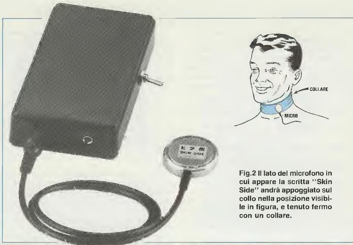
Fig.2 Il lato del microfono in cui appare la scritta "Skin Side" andrà appoggiato sul collo nella posizione visibile in figura, e tenuto fermo con un collare.
