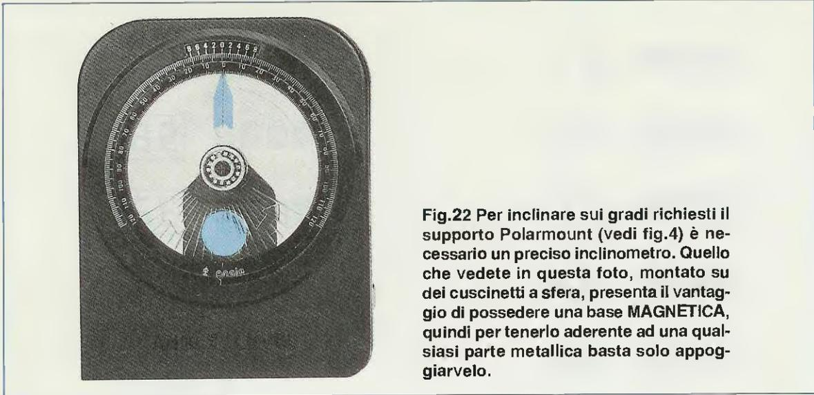
**Fig.22** Per inclinare sui gradi richiesti il supporto Polarmount (vedi fig.4) è necessario un preciso inclinometro. Quello che vedete in questa foto, montato su dei cuscinetti a sfera, presenta il vantaggio di possedere una base **MAGNETICA**, quindi per tenerlo aderente ad una qualsiasi parte metallica basta solo appoggiarlo.
