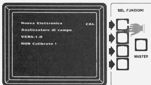
Fig.22 La prima volta che accenderemo l'Analizzatore dovremo pigiare il tasto CAL ( calibrare ) e così sullo schermo del monitor apparirà la scritta che ci indica che il nostro Tuner NON è CALIBRATO.
