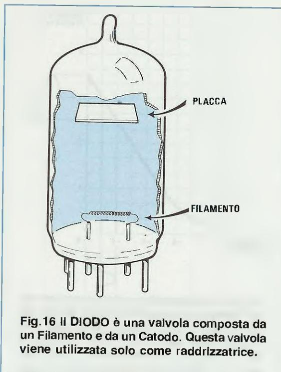
Fig.16 Il **DIODO** è una valvola composta da un **Filamento** e da un **Catodo**. Questa valvola viene utilizzata solo come **raddrizzatrice**.
