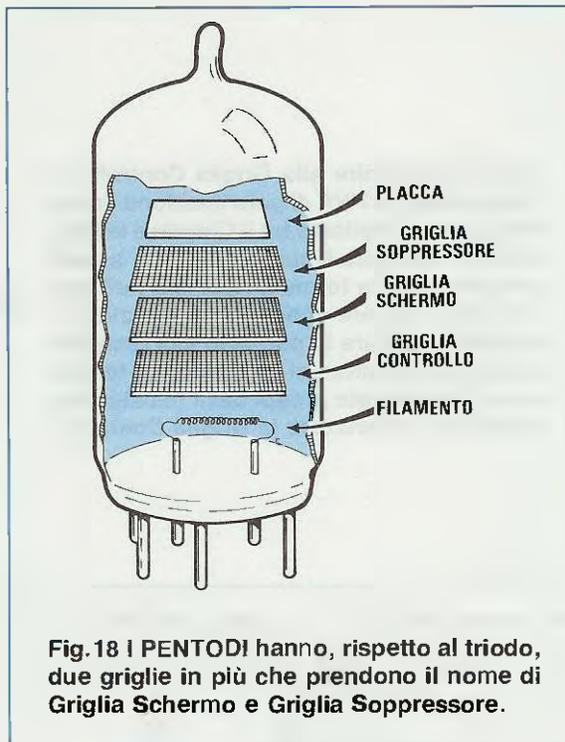
Fig.18 I PENTODI hanno, rispetto al triodo, due griglie in più che prendono il nome di Griglia Schermo e Griglia Soppressore.
