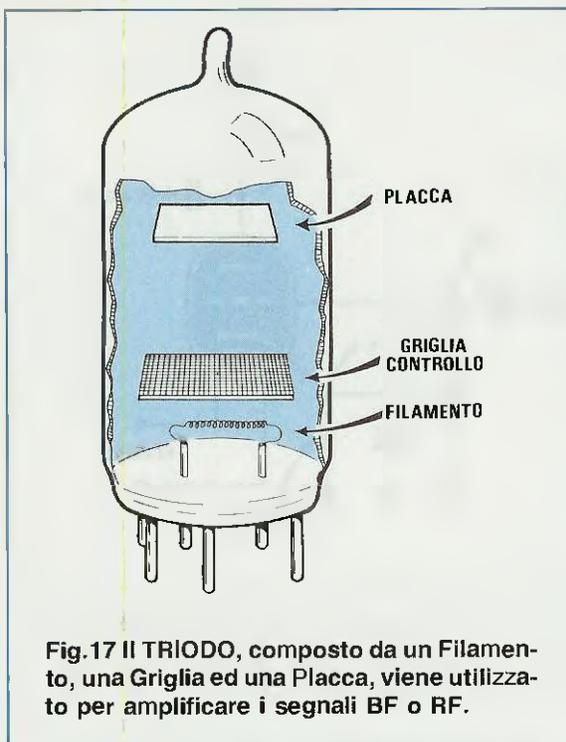
Fig.17 Il TRIODO, composto da un Filamento, una Griglia ed una Placca, viene utilizzato per amplificare i segnali BF o RF.
