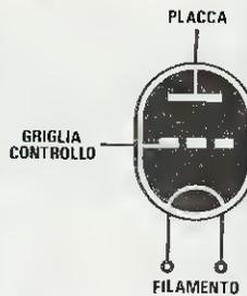
Fig.24 Simbolo grafico di un Triodo sprovvisto di Catodo.
