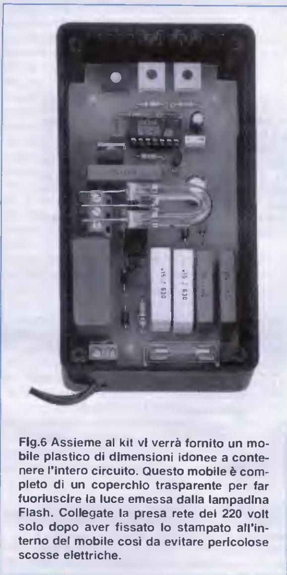
**Fig.6** Assieme al kit vi verrà fornito un mobile plastico di dimensioni idonee a contenere l'intero circuito. Questo mobile è completo di un coperchio trasparente per far fuoriuscire la luce emessa dalla lampadina Flash. Collegate la presa rete dei 220 volt solo dopo aver fissato lo stampato all'interno del mobile così da evitare pericolose scosse elettriche.
