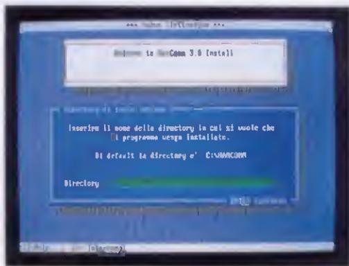
Fig.1 Dopo aver caricato il programma nell'Hard-Disk, dovete scompattarlo. Digitate `CD:\HAMCOMM>installa` poi Enter.
