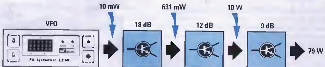
**Fig.20** Se sull'uscita dello stadio di fig.18 applichiamo un terzo transistor che guadagna in potenza 9 dB, sulla sua uscita otterremo 12,5 Watt, mentre se lo applichiamo sullo stadio di fig.19 riusciremo ad ottenere, in via teorica, una potenza di ben 79 Watt.
