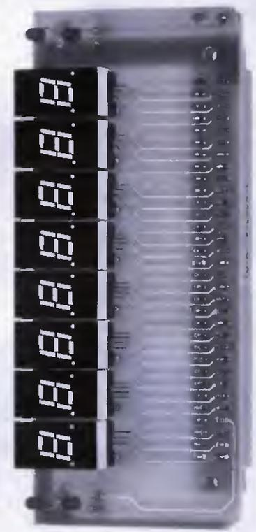
Fig.16 Foto della scheda display. Nella parte posteriore di questo circuito stampato va inserito il connettore femmina che dovrete innestare sul connettore maschio inserito nella scheda base di fig.15. Sulla parte frontale dovrete inserire gli zoccoli per innestare gli otto display di colore verde. In fig.25 è riportato lo schema pratico di montaggio dello stadio display.
