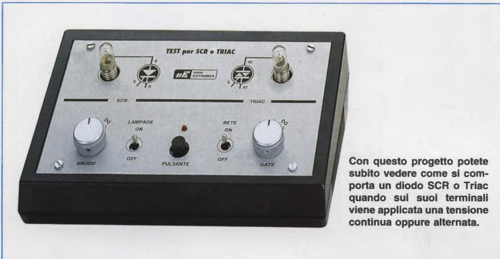
Con questo progetto potete subito vedere come si comporta un diodo SCR o Triac quando sui suoi terminali viene applicata una tensione continua oppure alternata.
