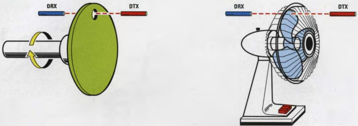
Fig.10 Il sistema più affidabile per leggere il numero di giri di un albero consiste nell'applicare sul suo perno un disco con uno o più fori in modo da interrompere il fascio a raggi infrarossi. Per misurare la velocità di un ventilatore potrete collocare i due fotodiodi ai due lati delle pale rotanti, purché queste non risultino trasparenti.
