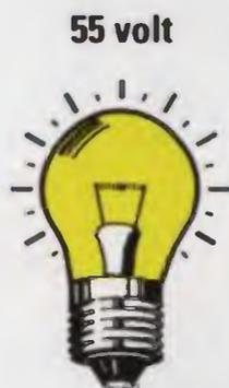
Fig.556 Se eccitiamo il Gate con un impulso positivo quando la semionda positiva ha già compiuto 3/4 del suo ciclo e nuovamente lo eccitiamo quando la semionda ha compiuto 3/4 del suo ciclo, sull'Anodo 2 preleveremo una tensione pari a 55 volt.
