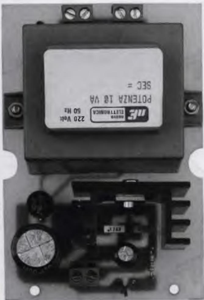
Fig.9 Qui sopra, la foto ridotta dell'alimentatore LX.1348. Questo circuito va racchiuso entro un mobile plastico (vedi fig.11), per tenere isolate le piste dello stampato percorse dalla tensione di rete del 220 volt.
