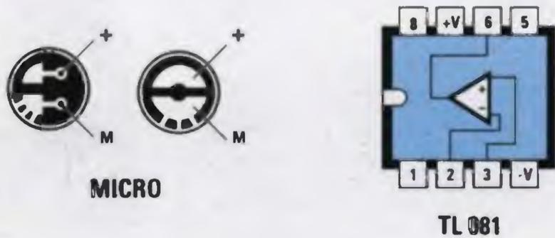
Fig.3 In alto le connessioni del piccolo microfono preamplificato viste da dietro, dell'integrato TL.081 viste da sopra e del transistor 2N.918 viste da sotto. Il terminale di "schermo" indicato con una S va collegato a massa.
