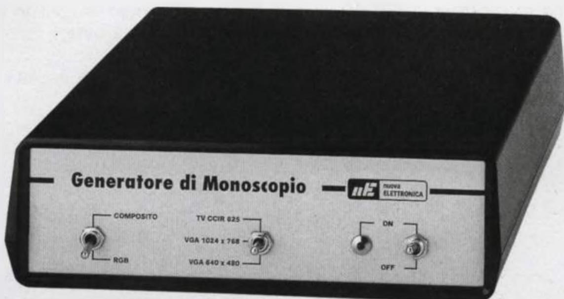
Fig.2 Come si presenta il pannello frontale del Generatore di monoscopio per televisori e monitor VGA.
