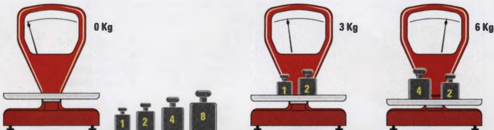
Fig.617 Con questi soli quattro pesi 1-2-4-8 è possibile far apparire sui display tutti i numeri da 0 a 9. Ammesso di avere una bilancia e quattro pesi da 1-2-4-8 Kg, per ottenere 3 Kg sarà sufficiente porre sul piatto un peso da 1 Kg ed uno da 2 Kg. Per ottenere 6 Kg sarà sufficiente collocare sul piatto un peso da 2 Kg ed uno da 4 Kg, mentre per ottenere 9 Kg sarà sufficiente porre sul piatto un peso da 1 Kg ed uno da 8 Kg.
