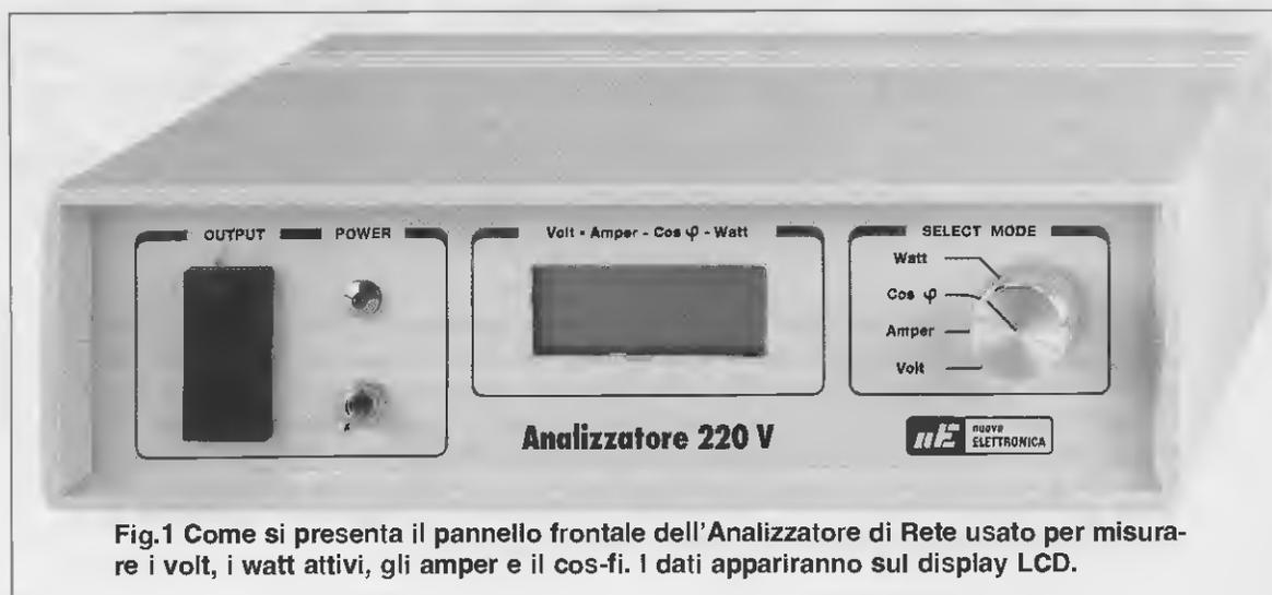
Fig.1 Come si presenta il pannello frontale dell'Analizzatore di Rete usato per misurare i volt, i watt attivi, gli amper e il cos-fi. I dati appariranno sul display LCD.
