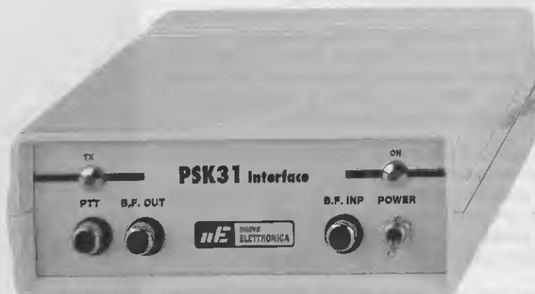
Collegata la presa **seriale** presente in questa interfaccia a quella del computer (vedi **CONN.1** in basso nello schema elettrico di fig.2), appena daremo la conferma **trasmetti** pigiando il tasto funzione **F12**, il computer applicherà sul piedino 7 del **CONN.1** una tensione positiva che, oltre ad accendere il diodo led **DL2**, ecciterà anche il **fotodiodo emittente** del fotoaccoppiatore **OC3**.
