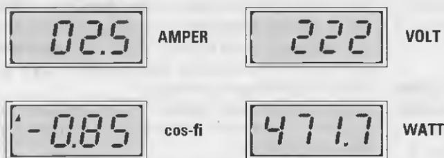
Fig.5 Con il nostro Analizzatore potete misurare gli amper, i volt, il cos-fi e i watt. In presenza di uno sfasamento Induttivo, vedrete apparire sul display, alla sinistra del numero, il segno -.
