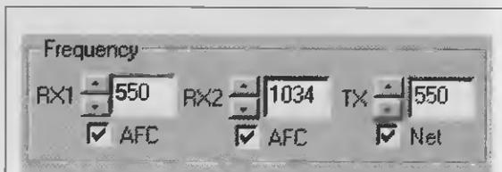
**Fig.37** Nei piccoli riquadri di "**Frequency**" appaiono i valori delle frequenze che avrete selezionato cliccando nelle finestre delle figg.33-34. Se avrete abilitato **Net** (vedi riquadro a destra), il programma trasmetterà sulla stessa frequenza di **RX1**.
