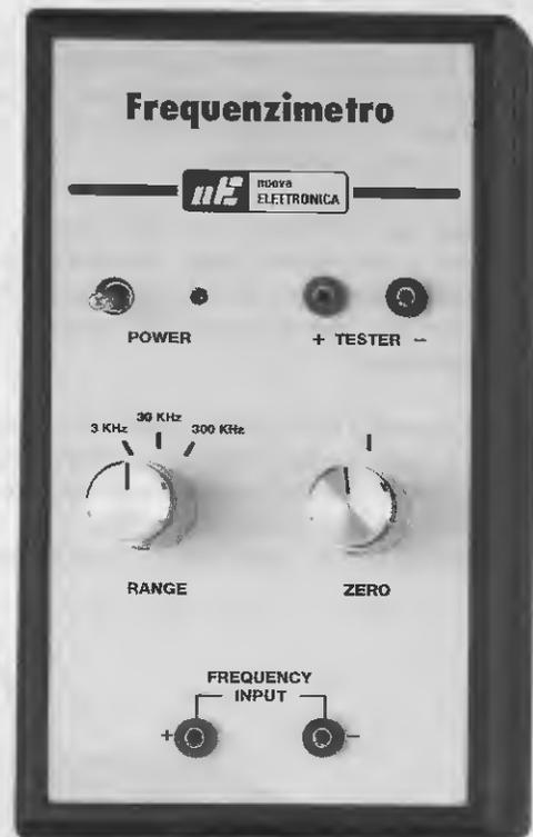
Fig.571 A destra, ecco come si presenta il pannello frontale del mobile. Le quattro boccole vanno collegate al circuito stampato con degli spezzi di filo di rame flessibile isolato in plastica (vedi fig. 566).
