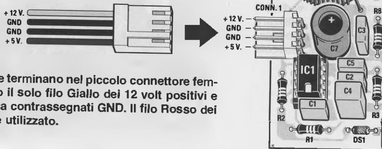
**Fig.10** Dei quattro fili che terminano nel piccolo connettore femmina, abbiamo utilizzato il solo filo Giallo dei 12 volt positivi e i due fili Neri della massa contrassegnati GND. Il filo Rosso dei 5 volt positivi non viene utilizzato.
