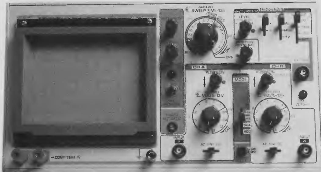
**Fig.14** Chi possiede un oscilloscopio dovrà ruotare il cursore del trimmer R12 fino a visualizzare sullo schermo un segnale la cui ampiezza raggiunga un valore di 4 volt picco-picco che corrispondono a 1,4 volt efficaci. Se possedete un frequenzimetro digitale, vi sarà molto più facile ottenere un valore di frequenza esatto, ritoccando leggermente i valori dei tre condensatori CX o delle due resistenze RX.
