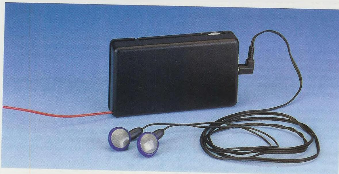
**Fig.2** Il mobile del ricevitore ha, invece, queste dimensioni: Lunghezza 180 mm, Larghezza 60 mm, Spessore 24 mm. Come si vede in fig.11, in questo mobile è presente un vano per la pila di alimentazione da 9 volt. Nella presa uscita BF del ricevitore (vedi fig.7) potrete inserire un auricolare o una comune cuffia.
