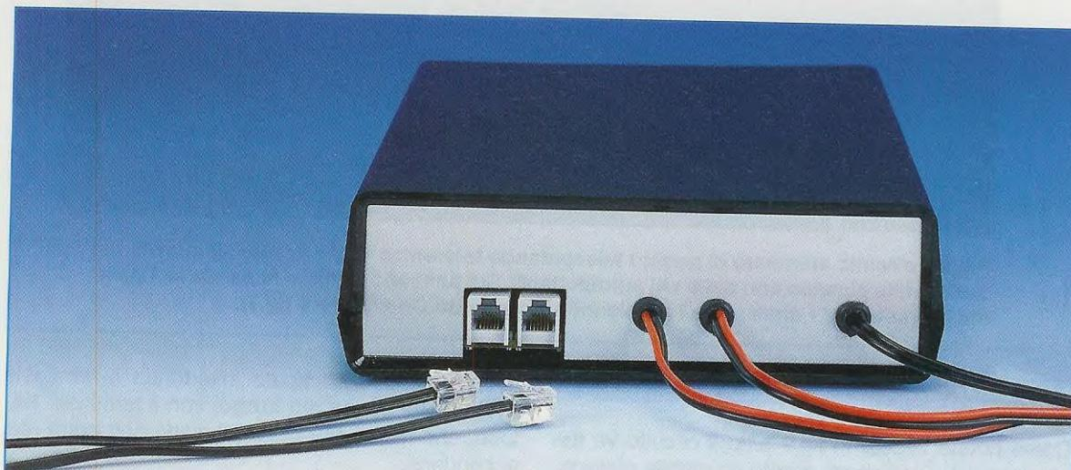
**Fig.10** In uno dei due **Plugs** femmina presenti sul pannello posteriore inserirete il **Plug** maschio che avrete sfilato dal corpo del vostro telefono e nell'altro **Plug** femmina inserirete il **Plug** maschio presente nello spezzone di cavo inserito nel kit. L'altro **Plug** maschio presente in questo spezzone di cavetto deve essere inserito nel **Plug** femmina presente nel vostro apparecchio telefonico (vedi fig.3).
