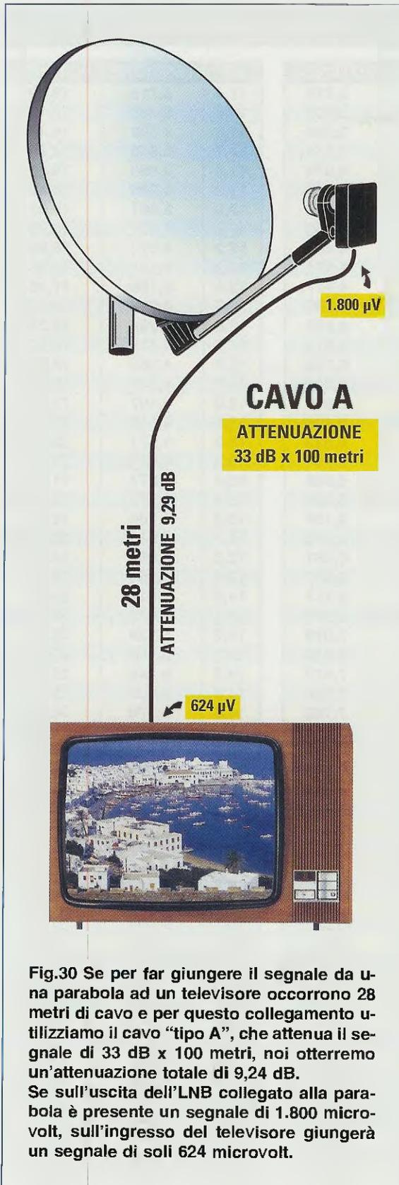
**Fig.30** Se per far giungere il segnale da una parabola ad un televisore occorrono 28 metri di cavo e per questo collegamento utilizziamo il cavo "tipo A", che attenua il segnale di 33 dB x 100 metri, noi otterremo un'attenuazione totale di 9,24 dB. Se sull'uscita dell'LNB collegato alla parabola è presente un segnale di 1.800 microvolt, sull'ingresso del televisore giungerà un segnale di soli 624 microvolt.
