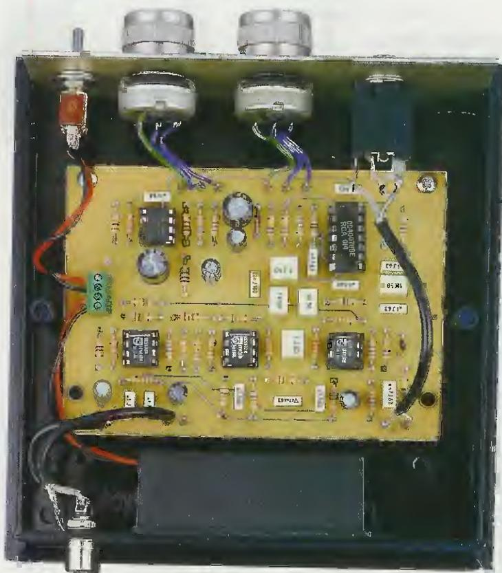
**Fig.9** Quando dai cavetti schermati sfilate la calza di schermo per saldarla sui terminali di massa del circuito stampato, sulla presa Jack d'entrata e sulle prese d'uscita, controllate sempre che non rimanga volante qualche sottilissimo filo della calza di schermo, che potrebbe venire a contatto con il terminale del segnale cortocircuitandolo.
