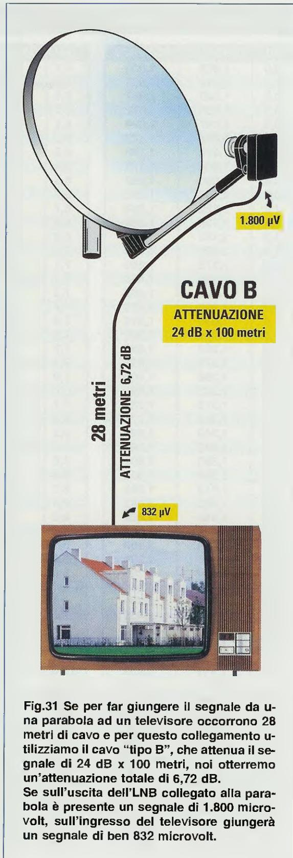
**Fig.31** Se per far giungere il segnale da una parabola ad un televisore occorrono 28 metri di cavo e per questo collegamento utilizziamo il cavo "tipo B", che attenua il segnale di 24 dB x 100 metri, noi otterremo un'attenuazione totale di 6,72 dB. Se sull'uscita dell'LNB collegato alla parabola è presente un segnale di 1.800 microvolt, sull'ingresso del televisore giungerà un segnale di ben 832 microvolt.
