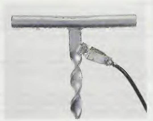
Fig.15 Per collegare elettricamente le morsettiere A-B alle aste conficcate nel terreno, potete applicare sull'estremità di ogni filo una pinza robusta.
