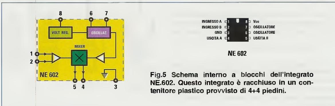
Fig.5 Schema interno a blocchi dell'integrato NE.602. Questo integrato è racchiuso in un contenitore plastico provvisto di 4+4 piedini.
