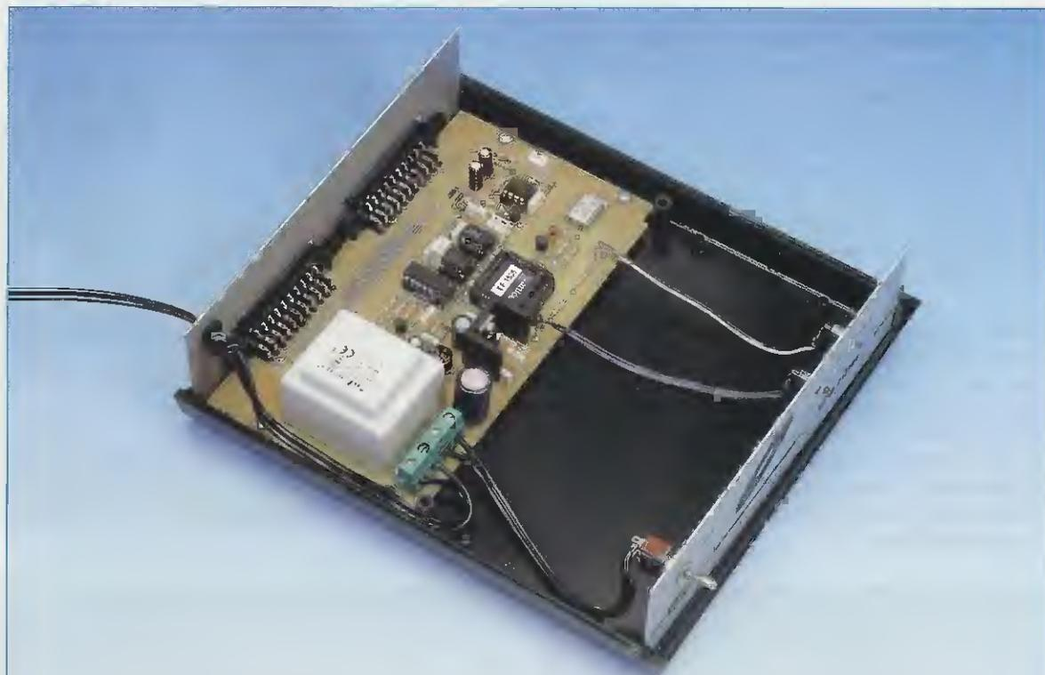
**Fig.13** Il circuito stampato va fissato con quattro viti autofilettanti all'interno del mobile plastico che abbiamo scelto per questo progetto. Dal pannello posteriore escono le due prese Scart (vedi figg.7-8), mentre sul pannello anteriore trovano posto l'interruttore di accensione S1 e le due gemme cromate per i diodi led DL1-DL2.
