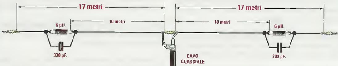
**Fig.30** Un'altra antenna bi-banda che potete realizzare per i 3,5 e i 7 MHz è quella visibile nel disegno, che utilizza due impedenze da 6 microhenry con in parallelo un condensatore ceramico da 330 picofarad. Nel nostro volume "Le ANTENNE riceventi e trasmettenti" potete trovare altri tipi di antenne idonee per i 3,5 e i 7 MHz.
