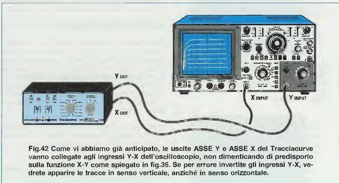
Fig.42 Come vi abbiamo già anticipato, le uscite ASSE Y e ASSE X del Tracciacurve vanno collegate agli ingressi Y-X dell'oscilloscopio, non dimenticando di predisporlo sulla funzione X-Y come spiegato in fig.35. Se per errore invertite gli ingressi Y-X, vedrete apparire le tracce in senso verticale, anziché in senso orizzontale.
