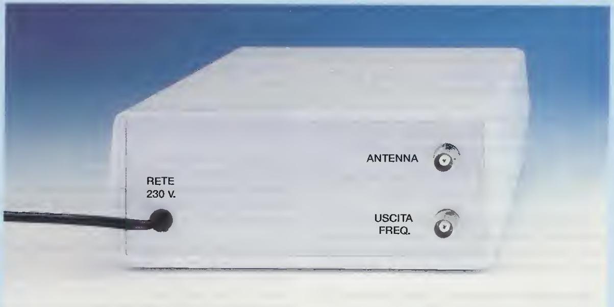
**Fig.28** Sul pannello posteriore del mobile fissate due prese femmina BNC (vedi fig.20). Quella superiore serve per entrare con il segnale captato dall'antenna, mentre quella inferiore serve per prelevare il segnale da applicare ad un frequenzimetro digitale (come il Kit LX.1525), per conoscere la frequenza sulla quale si è sintonizzati.
