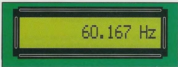
Fig.4 Se sull'ingresso B applichiamo frequenze minori di 65.000 Hz, il microprocessore sceglierà automaticamente una base di tempi di 1 secondo, la lettura risulterà più lenta, ma avremo il vantaggio di vedere apparire sul display anche le unità degli Hertz.
