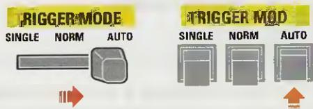
**Fig.26** Sul pannello di ogni oscilloscopio c'è un selettore contraddistinto dalla scritta TRIGGER MODE. Questo selettore può essere del tipo a slitta (vedi disegno a sinistra) oppure a pulsanti (vedi disegno a destra). In entrambi i casi dovete spostare la levetta o premere il pulsante per attivare la funzione AUTO.
