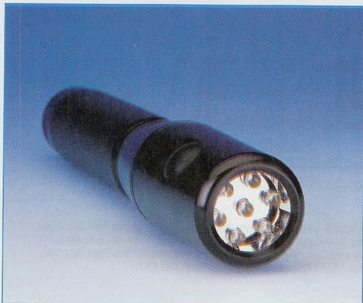
**Fig.10** Utilizzando dei diodi led Bianchi tipo flash, si possono realizzare delle potenti torce, perchè la luce emessa da questi diodi led è intensa quasi quanto quella di un piccolo flash.
