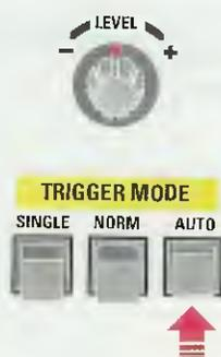
Fig.24 Per bloccare in automatico la traccia di un segnale occorre premere il pulsante **AUTO** del TRIGGER MODE. Se la traccia non rimane ferma allora si può agire sulla piccola manopola di LEVEL, ruotandola verso il + o verso il - fino a bloccare l'immagine sullo schermo.
