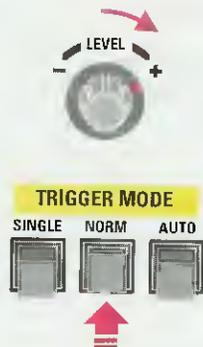
Fig.26 Mantenendo premuto il pulsante **NORMAL**, se ora ruotate la piccola manopola del LEVEL verso il segno +, vedrete spostarsi il punto di partenza del segnale verso l'alto. Se in fig.25 la traccia del segnale partiva dal centro schermo, ora la traccia parte da 2 quadretti sopra.
