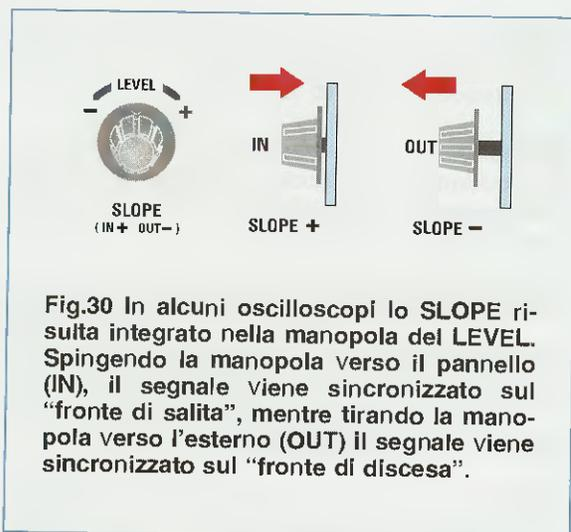
**Fig.30** In alcuni oscilloscopi lo **SLOPE** risulta integrato nella manopola del **LEVEL**. Spingendo la manopola verso il pannello (**IN**), il segnale viene sincronizzato sul "fronte di salita", mentre tirando la manopola verso l'esterno (**OUT**) il segnale viene sincronizzato sul "fronte di discesa".
