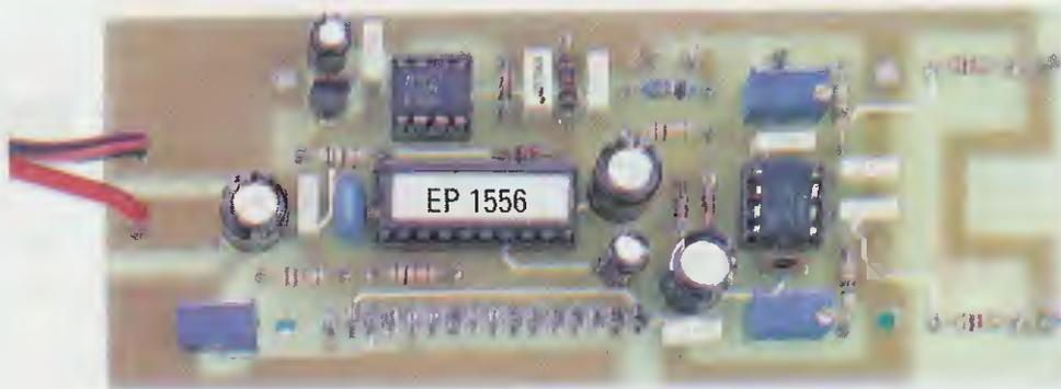
**Fig.13** Foto del circuito già montato e pronto per l'uso. Questo Voltmetro - Amperometro può essere inserito all'interno di un qualsiasi Alimentatore Stabilizzato, purché si riesca a prelevare dallo stesso una tensione stabilizzata di 5 volt per poterlo alimentare, diversamente si adotterà la soluzione visibile in fig.14.
