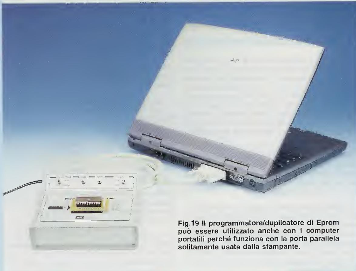
**Fig.19** Il programmatore/duplicatore di Eprom può essere utilizzato anche con i computer portatili perché funziona con la porta parallela solitamente usata dalla stampante.
