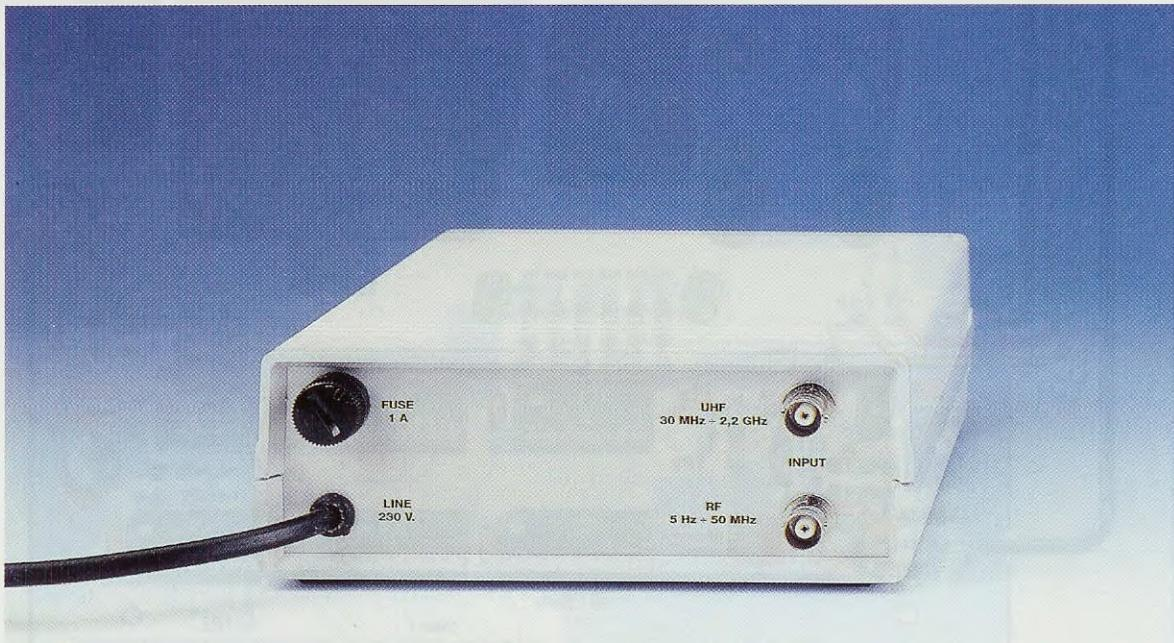
**Fig.10** Nel pannello posteriore del mobile dovete fissare i due BNC per entrare con i segnali RF e UHF da misurare. In fig.11 potete vedere come questi due BNC risultano collegati al circuito stampato del frequenzimetro e al modulo SMD.
