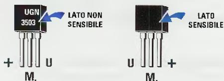
Fig.3 Nella figura a lato sono indicate le connessioni dell'integrato UGN.3503. Il lato sensibile, che va posto a contatto del nucleo in ferrite, è riconoscibile dall'assenza della sigla.
