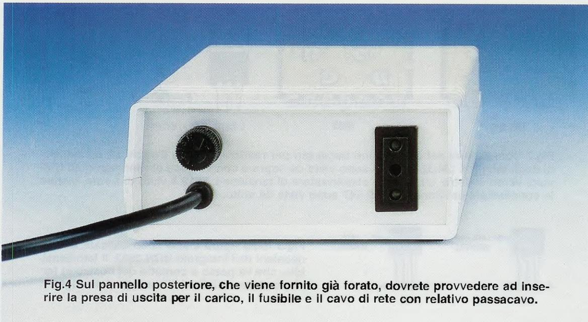
Fig.4 Sul pannello posteriore, che viene fornito già forato, dovrete provvedere ad inserire la presa di uscita per il carico, il fusibile e il cavo di rete con relativo passacavo.
