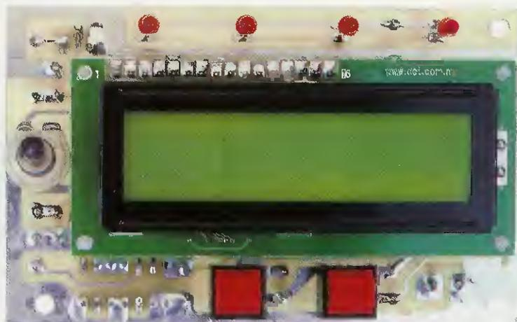
**Fig.13** In questa foto vi facciamo vedere il circuito stampato LX.1601 visto dal lato del Display. Nei fori presenti in alto sulla sinistra del circuito stampato dovete inserire un Doppio Connettore maschio come indicato in fig.16.
