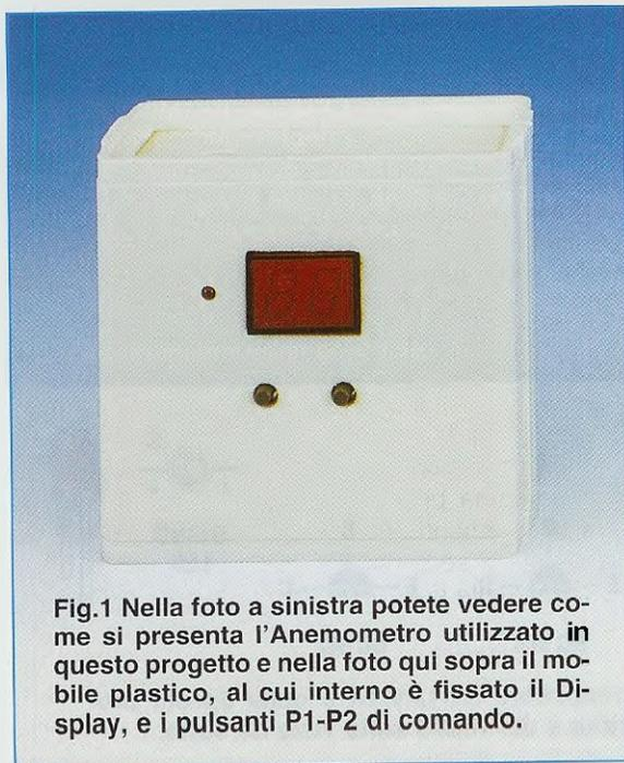
Fig.1 Nella foto a sinistra potete vedere come si presenta l'Anemometro utilizzato in questo progetto e nella foto qui sopra il mobile plastico, al cui interno è fissato il Display, e i pulsanti P1-P2 di comando.
