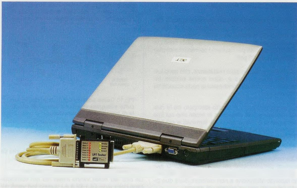
**Fig.12** Il tester per la linea parallela va collegato alla porta LPT (Line PrinTer) del vostro computer con un cavo provvisto di connettori a 25 poli pin to pin maschio/femmina.
