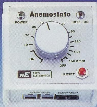
**Fig.7** Foto del contenitore che racchiude il nostro anemostato. Sul coperchio dovete montare il **potenziometro**, il **pulsante** e le ghiera cromate per i due diodi **led**.
