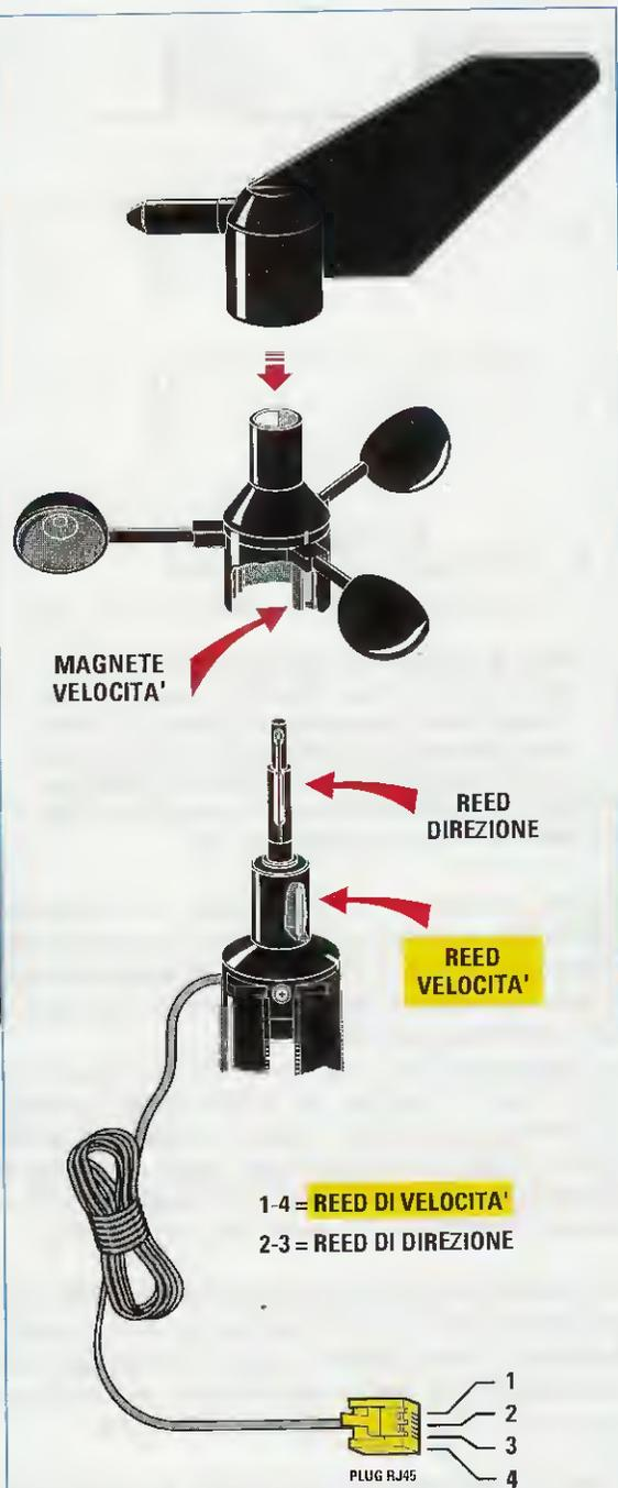
**Fig.1** L'anemometro con anemoscopio che forniamo insieme alla Weather Station presentata sulla rivista N.220 con la sigla **KM.100**, possiede due reed switch: uno per misurare la velocità del vento e l'altro per misurarne la direzione.
