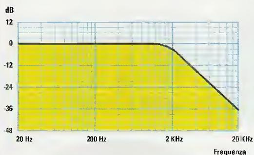
**Fig.26** Per misurare un filtro attivo si consiglia di prelevare il segnale dal BNC 2 e di applicare l'uscita del filtro sul BNC 1. Nel disegno il grafico di un filtro Passo Basso con taglio sui 2 KHz circa.
