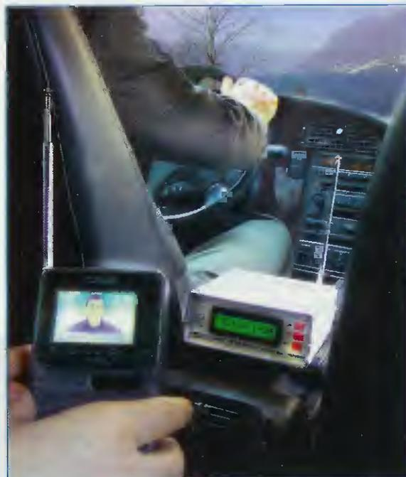
**Fig.5** Se collegate la presa audio di un piccolo televisore portatile all'Eccitatore FM, potrete utilizzare l'impianto stereo della vostra auto o del vostro camper per potenziare la riproduzione sonora.
