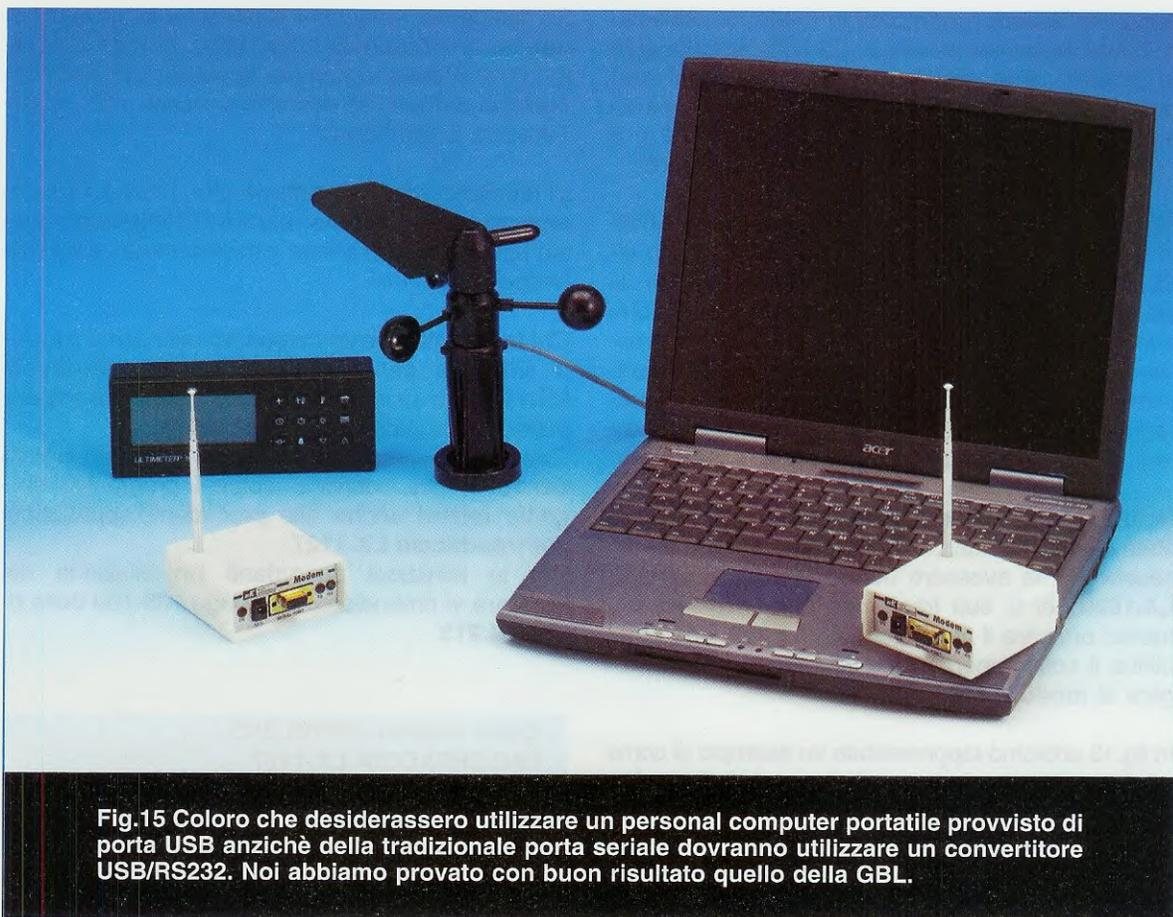
**Fig.15** Coloro che desiderassero utilizzare un personal computer portatile provvisto di porta USB anzichè della tradizionale porta seriale dovranno utilizzare un convertitore USB/RS232. Noi abbiamo provato con buon risultato quello della GBL.
