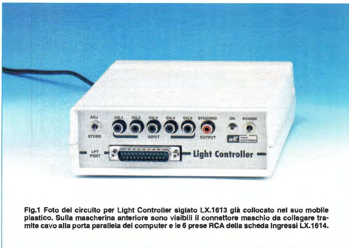
Questa interfaccia permette di gestire dei programmi di luce e consiste in una console con slider virtuali per graduare l'intensità luminosa di ogni canale. Il software prevede, inoltre, la possibilità di programmare sequenze di accensione e spegnimento delle lampade una di seguito all'altra.
