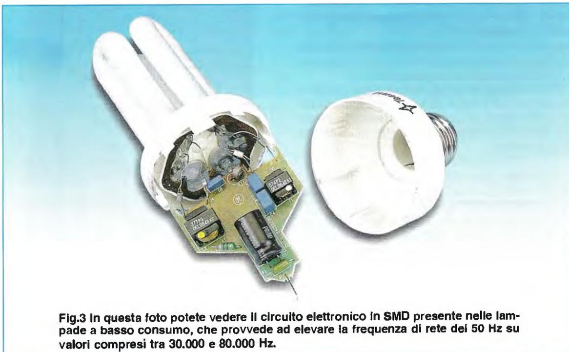
**Fig.3** In questa foto potete vedere il circuito elettronico in SMD presente nelle lampade a basso consumo, che provvede ad elevare la frequenza di rete dei 50 Hz su valori compresi tra 30.000 e 80.000 Hz.
