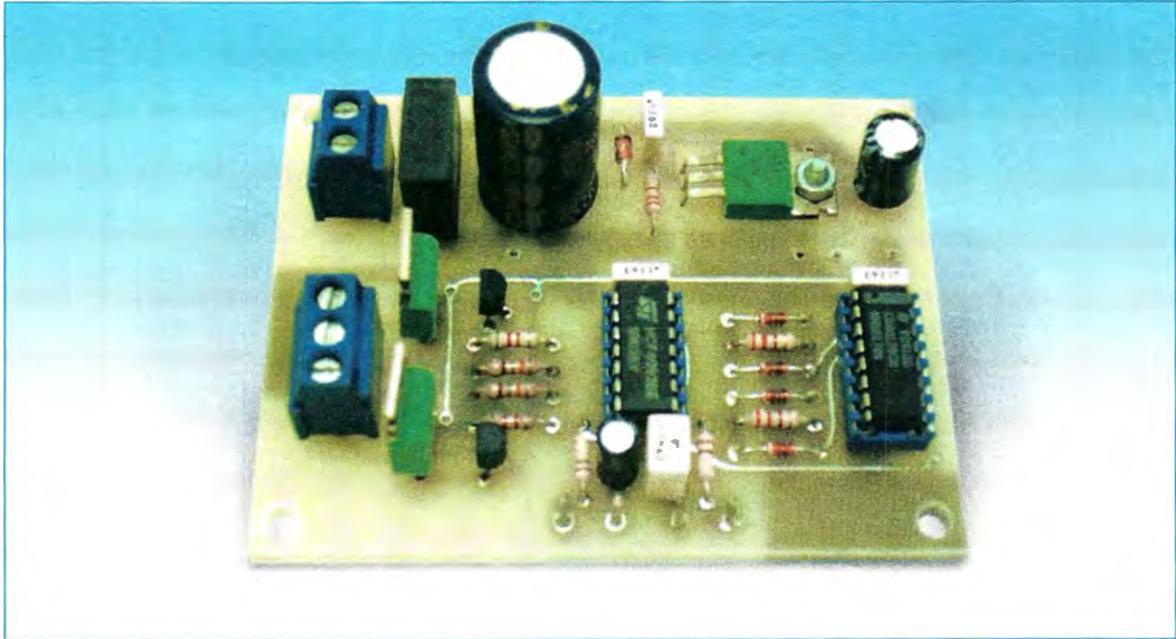
Per realizzare questo circuito abbiamo utilizzato dei diodi led tricolore, che possono accendersi ad intervalli regolari in rosso, oppure verde o giallo.
