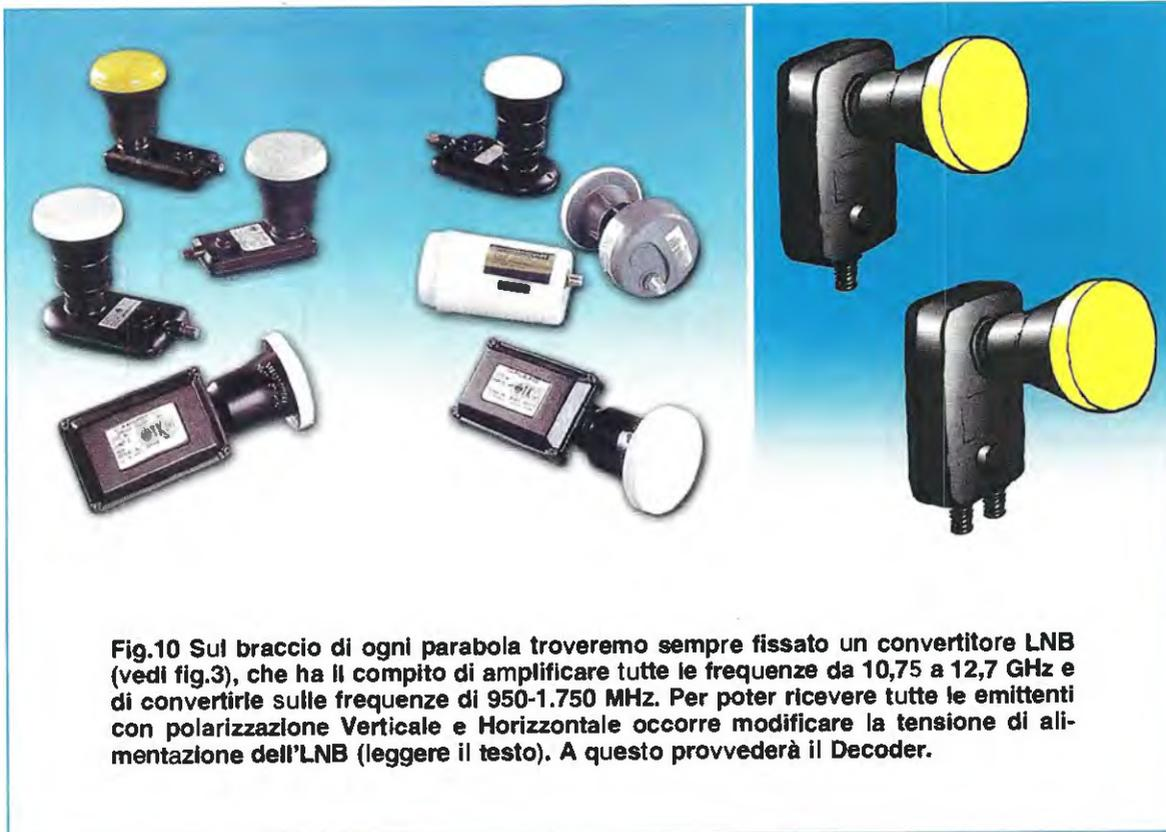
**Fig.10** Sul braccio di ogni parabola troveremo sempre fissato un convertitore LNB (vedi fig.3), che ha il compito di amplificare tutte le frequenze da 10,75 a 12,7 GHz e di convertirle sulle frequenze di 950-1.750 MHz. Per poter ricevere tutte le emittenti con polarizzazione Verticale e Horizontale occorre modificare la tensione di alimentazione dell'LNB (leggere il testo). A questo provvederà il Decoder.
