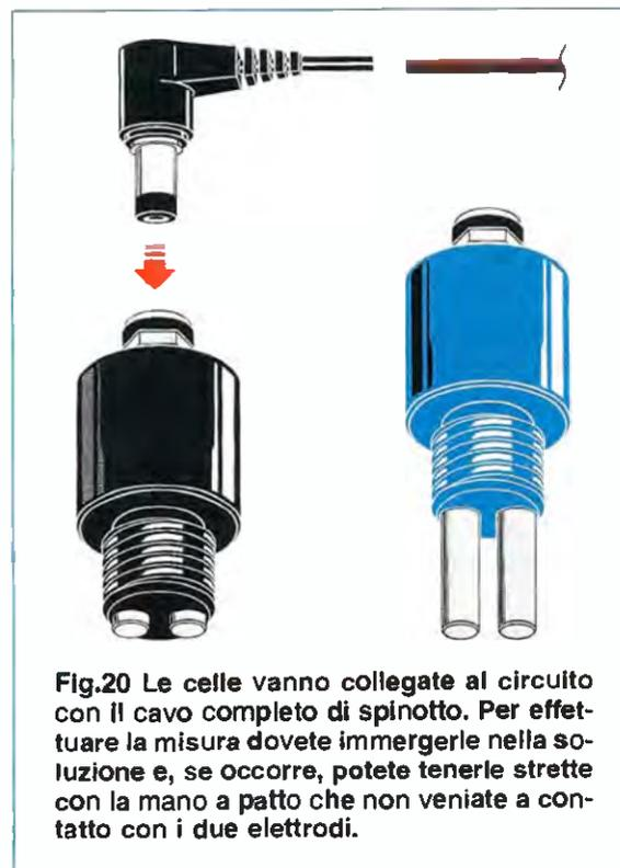
**Fig.20** Le celle vanno collegate al circuito con il cavo completo di spinotto. Per effettuare la misura dovete immergerle nella soluzione e, se occorre, potete tenerle strette con la mano a patto che non veniate a contatto con i due elettrodi.
