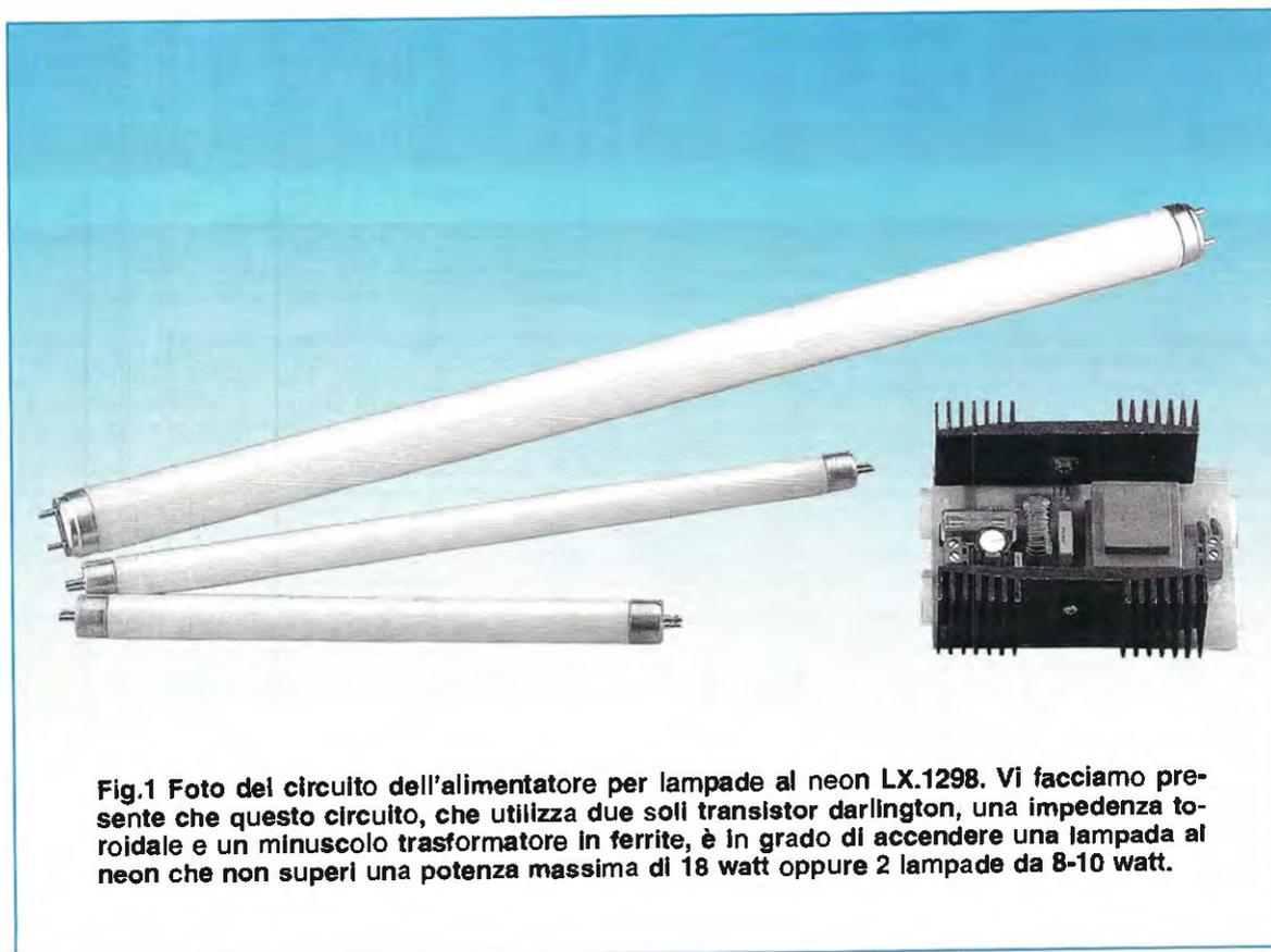
**Fig.1** Foto del circuito dell'alimentatore per lampade al neon LX.1298. Vi facciamo presente che questo circuito, che utilizza due soli transistor darlington, una impedenza toroidale e un minuscolo trasformatore in ferrite, è in grado di accendere una lampada al neon che non superi una potenza massima di 18 watt oppure 2 lampade da 8-10 watt.
