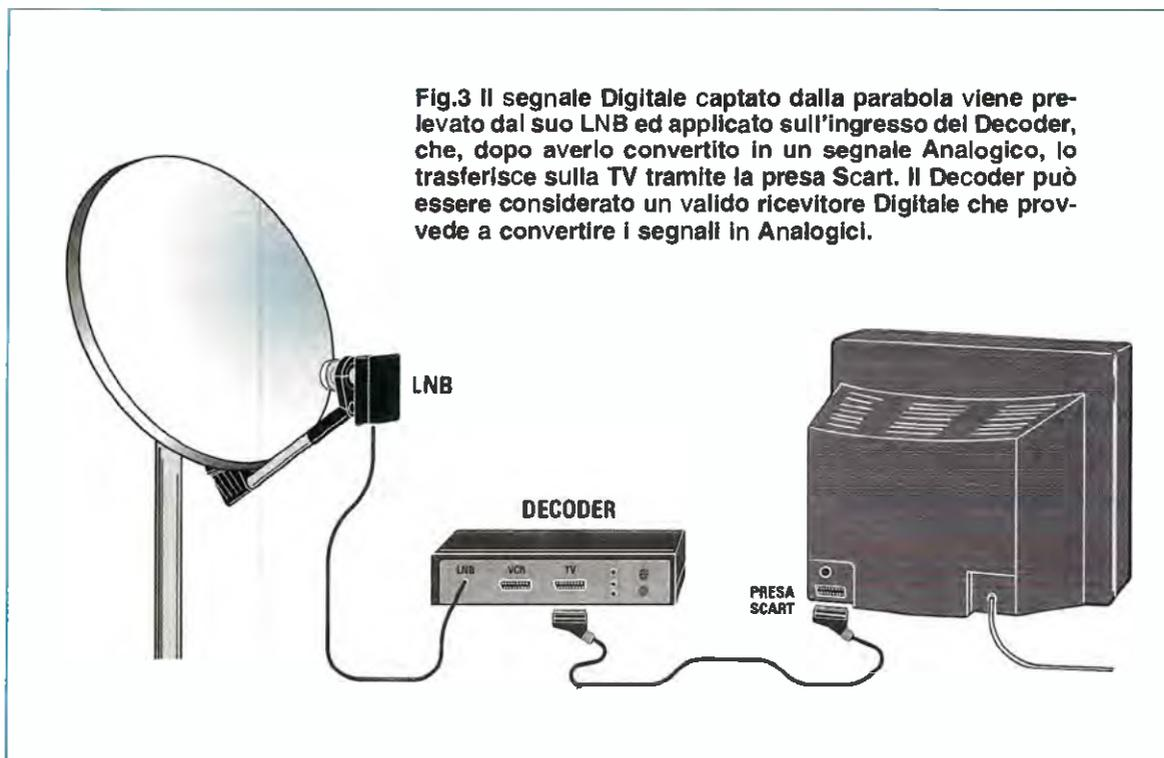
**Fig.3** Il segnale Digitale captato dalla parabola viene prelevato dal suo LNB ed applicato sull'ingresso del Decoder, che, dopo averlo convertito in un segnale Analogico, lo trasferisce sulla TV tramite la presa Scart. Il Decoder può essere considerato un valido ricevitore Digitale che provvede a convertire i segnali in Analogici.
