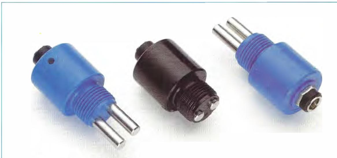
Fig.1 Quelle nella foto sono le celle conduttivimetriche K5 e K1 per il conduttivimetro visibile in alto. La K5, fotografata da entrambe le angolazioni, è di colore blu e va usata per acque oligominerali o poco mineralizzate, mentre la K1, di colore nero e con gli elettrodi molto corti, va usata per misure di acque molto salate, oltre i 1.000 microsiemens/cm.
