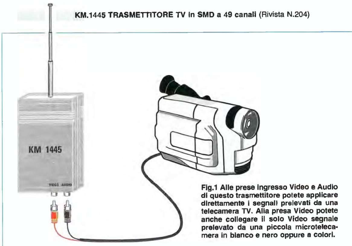
**Fig.1** Alle prese Ingresso Video e Audio di questo trasmettitore potete applicare direttamente i segnali prelevati da una telecamera TV. Alla presa Video potete anche collegare il solo Video segnale prelevato da una piccola microtelecamera in bianco e nero oppure a colori.
