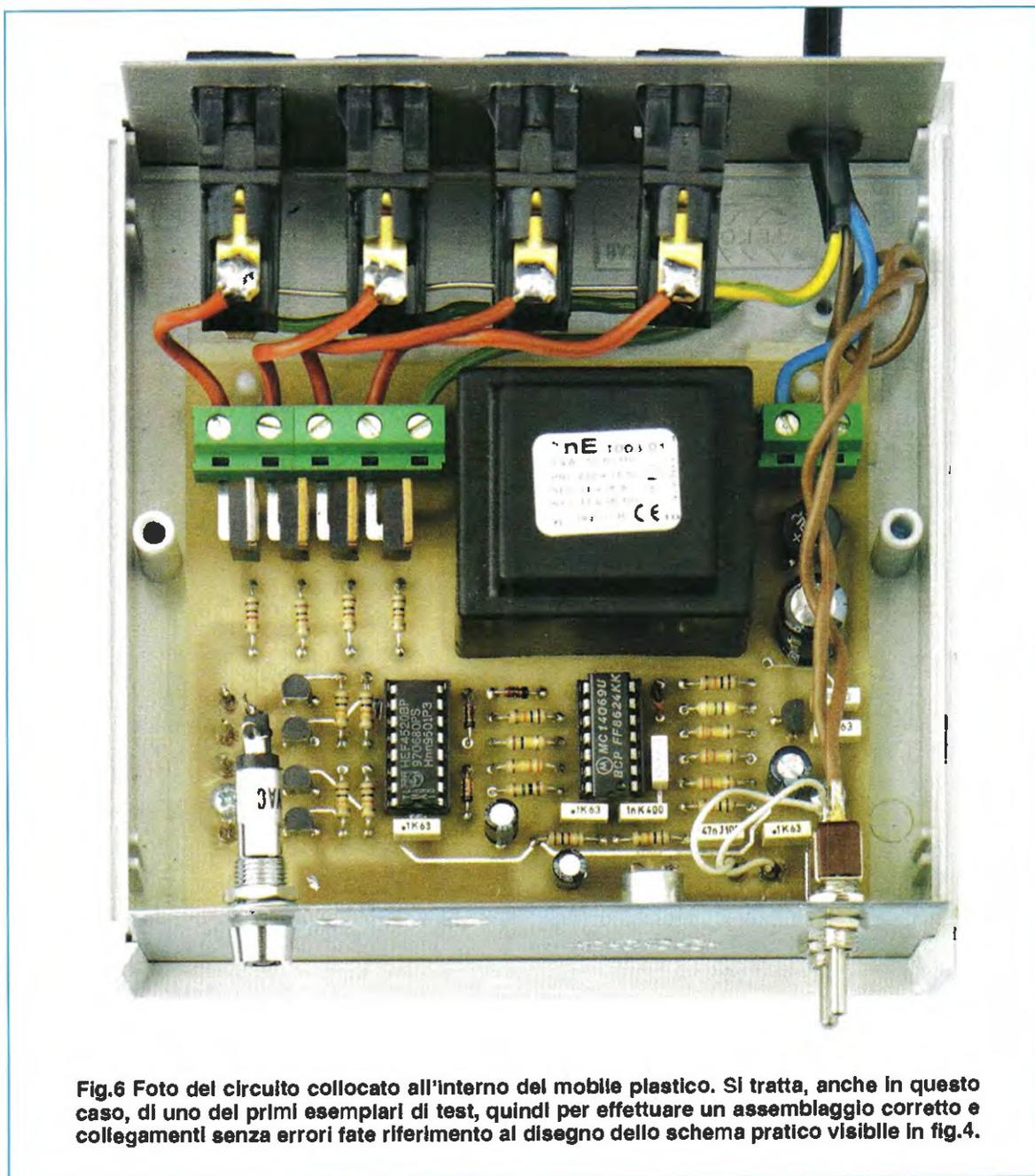
**Fig.6** Foto del circuito collocato all'interno del mobile plastico. Si tratta, anche in questo caso, di uno dei primi esemplari di test, quindi per effettuare un assemblaggio corretto e collegamenti senza errori fate riferimento al disegno dello schema pratico visibile in fig.4.
