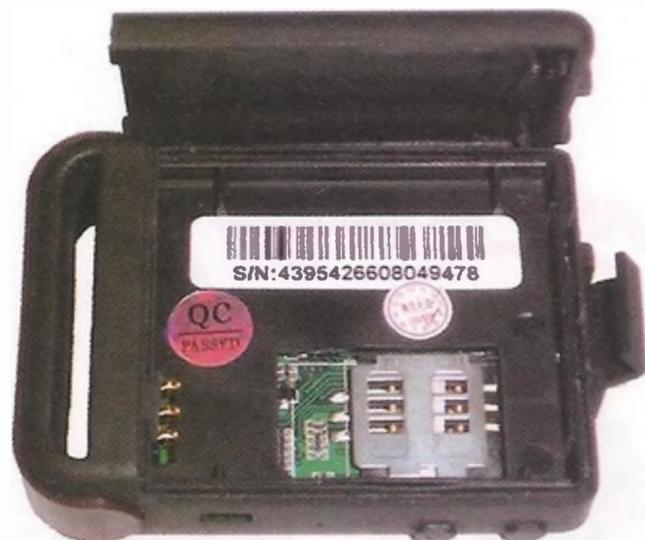
**Fig.10** Aprite TRACKER tirando verso l'esterno la leva in basso e alzate il coperchio per inserire negli spazi previsti la scheda SimCard e la batteria, quindi chiudete il coperchio.
