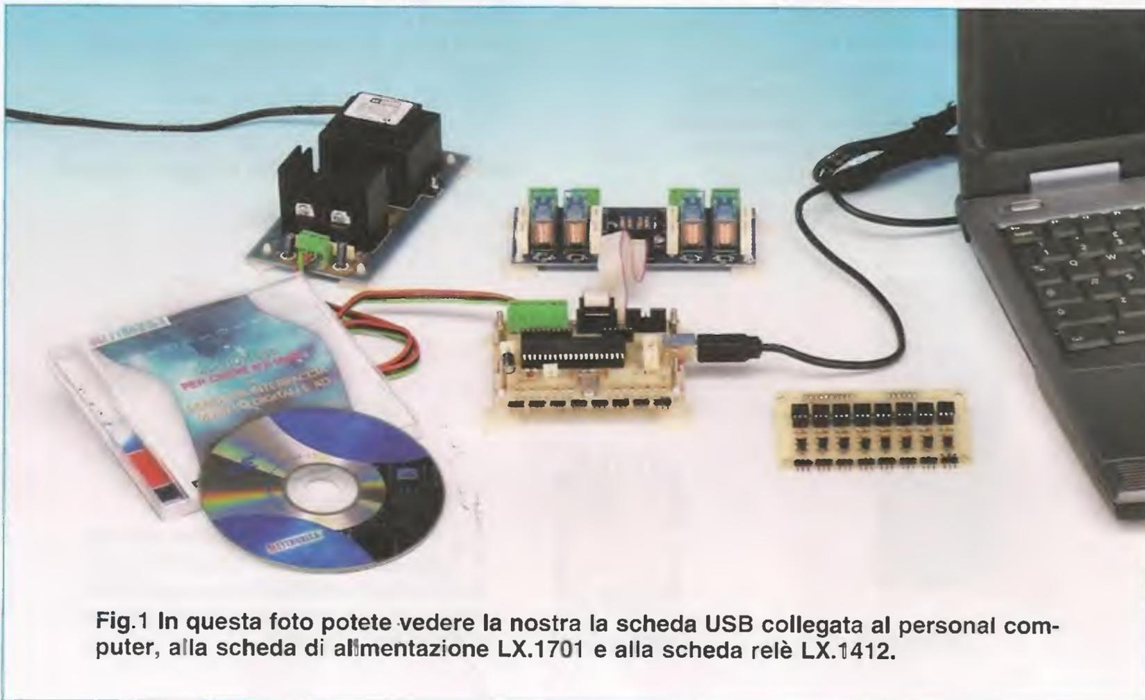
**Fig.1** In questa foto potete vedere la nostra la scheda USB collegata al personal computer, alla scheda di alimentazione LX.1701 e alla scheda relè LX.1412.
