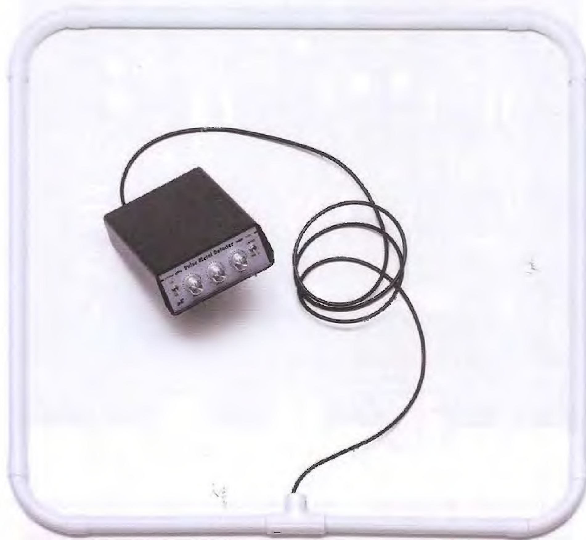
Fig.17 È qui riprodotta la foto della bobina quadrata da noi realizzata per eseguire i test del circuito e le prove pratiche.
