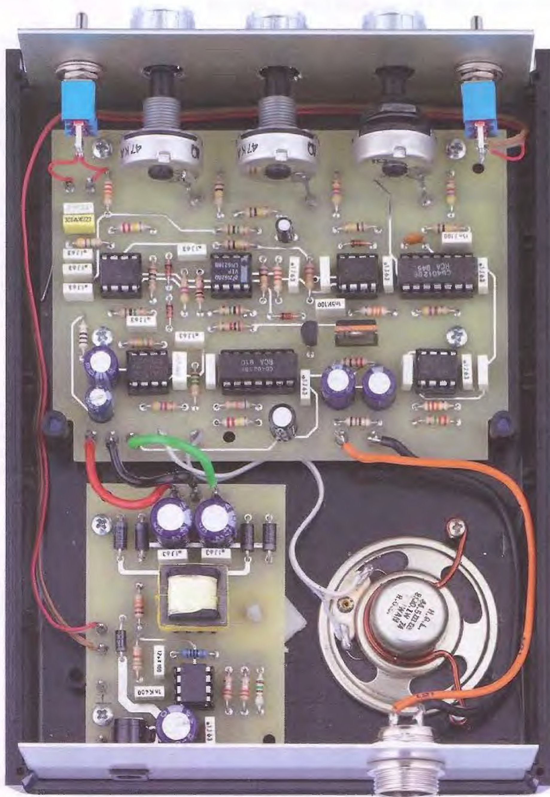
Fig.19 Il circuito del cercametalli e dell'alimentatore collocati nel mobile plastico qui visto dal retro. Potete notare come per mezzo di piccoli terminali metallici abbiamo risolto il problema del fissaggio del corpo dei tre potenziometri sul circuito stampato e come debbano essere fissati dall'interno del mobile i due interruttori di accensione e di alimentazione.
