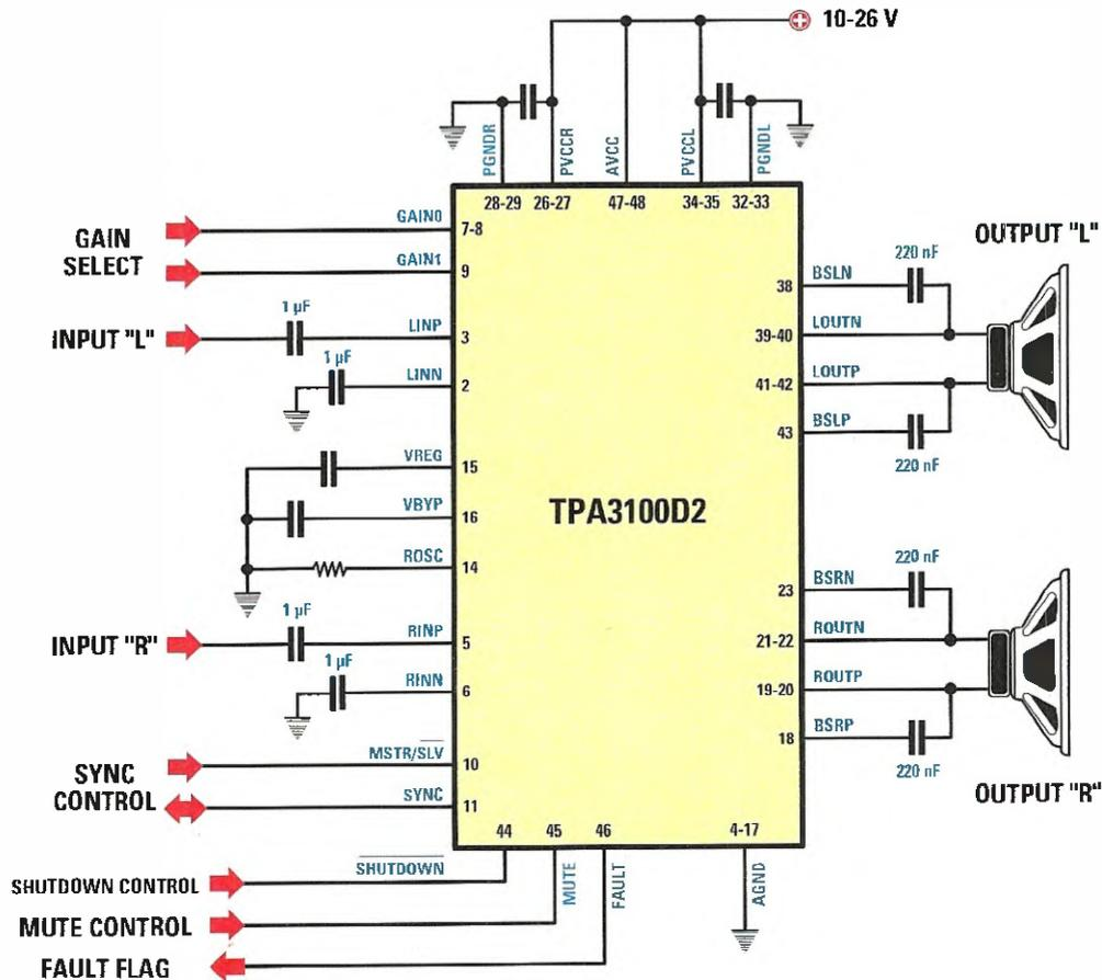
**Fig.9** Per farvi meglio comprendere il principio di funzionamento dell'integrato TPA3100D2 in figura vi proponiamo il suo schema di funzionamento semplificato. Per informazioni più dettagliate vi rimandiamo alla lettura dell'articolo.
