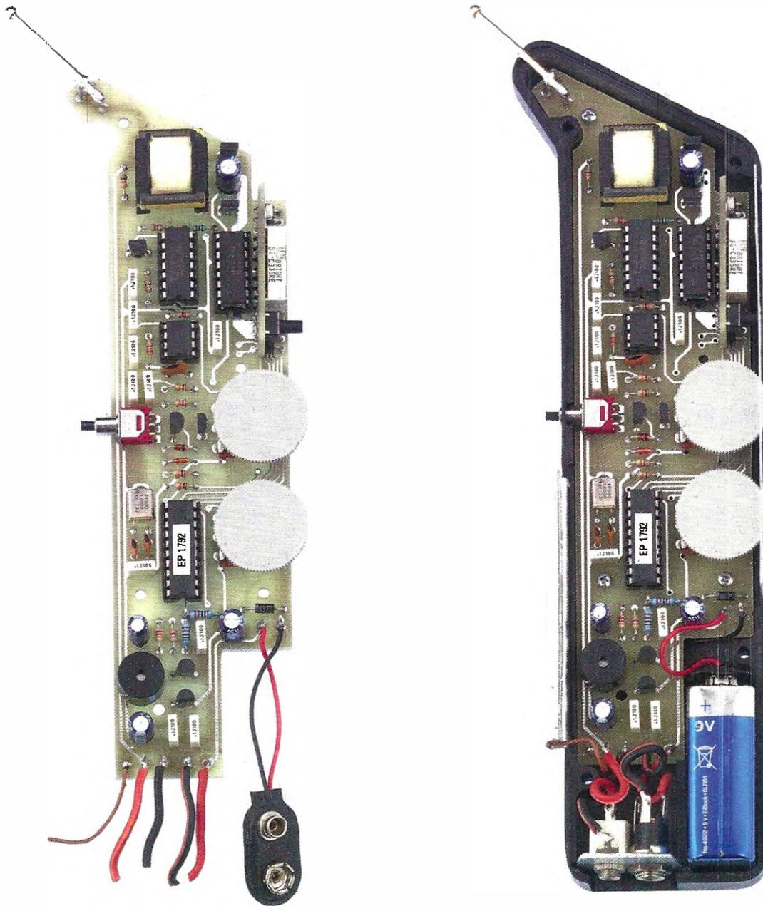
**Fig.9** A sinistra foto dello schema pratico di montaggio dell'elettroreflex e, a destra, lo stesso fissato alla base del manipolo appositamente realizzato.
