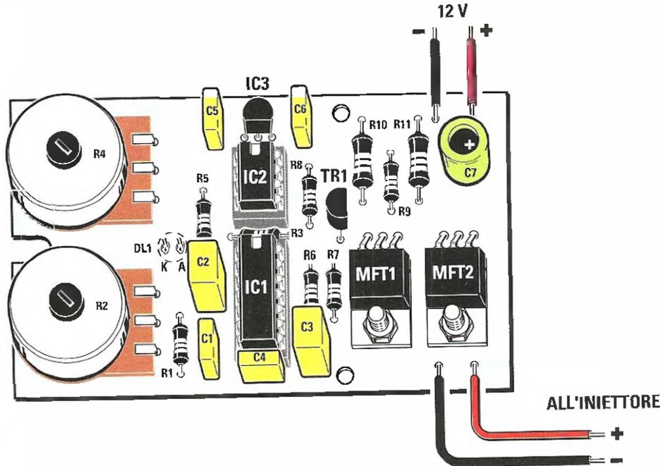
**Fig.5** Schema pratico di montaggio del circuito stampato del prova iniettori LX.1791. Seguendo le indicazioni fornite nell'articolo non incontrerete particolari difficoltà a portarne a termine la realizzazione.
