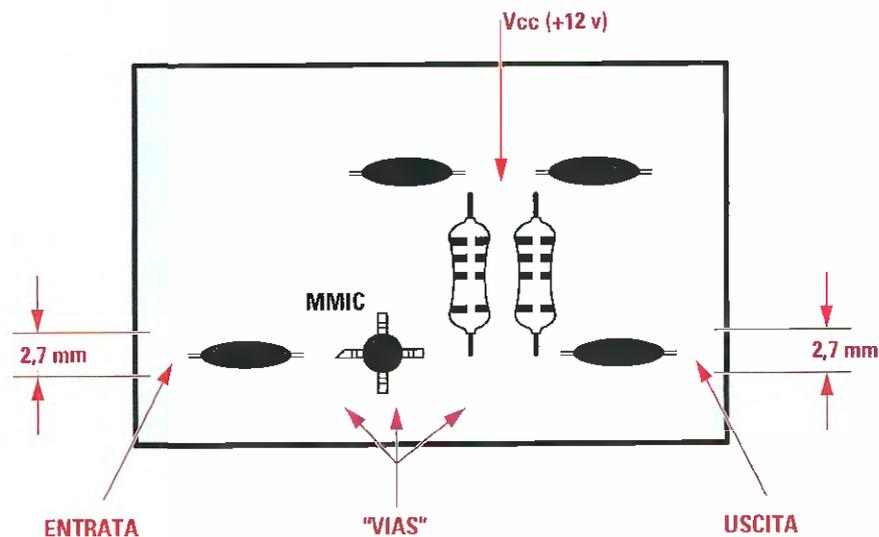
**Fig.5** In questo disegno potete vedere come deve essere realizzato in pratica il circuito amplificatore. Il piano inferiore di rame del circuito stampato funge da piano di massa e va pertanto collegato in diversi punti alla massa del piano superiore tramite fori metallizzati (VIAS) oppure normali fori al cui interno è posto un filo di rame che verrà saldato poi alla massa su entrambi i lati.
