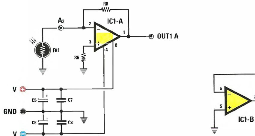
In figura è riprodotto l'integrato **IC1/A** collegato come convertitore corrente/tensione per **convertire** la corrente che attraversa **FR1** in una **tensione**.
