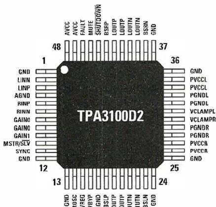
**Fig. 8** Schema a blocchi dell'integrato tipo TPA3100D2 e relativa piedinatura. Nell'articolo troverete la descrizione dei piedini principali e delle loro funzioni.
