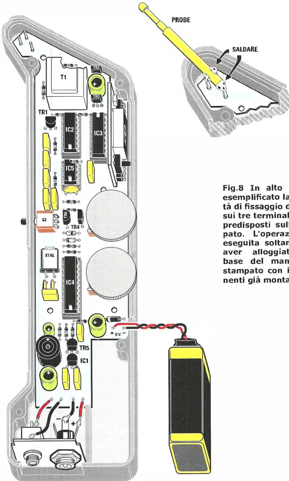
Fig.8 In alto abbiamo esemplificato la modalità di fissaggio del probe sui tre terminali a spillo predisposti sullo stampato. L'operazione va eseguita soltanto dopo aver alloggiato sulla base del manipolo lo stampato con i componenti già montati.
