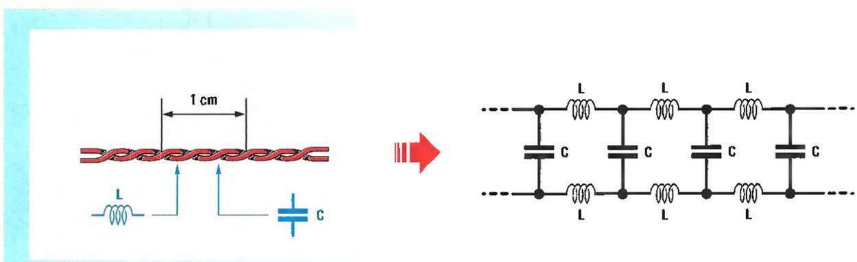
**Fig.3** Attorcigliando insieme due fili si ottiene una "linea di trasmissione" la cui impedenza dipende dal numero dei giri per centimetri di lunghezza.
