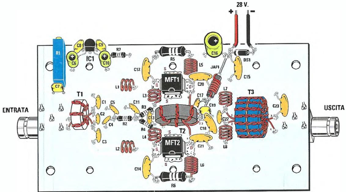
**Fig.13 Schema pratico di montaggio dell'amplificatore RF. Una volta realizzate le bobine e i trasformatori seguendo le indicazioni fornite nell'articolo ed esemplificate nelle illustrazioni, saldatele sullo stampato nelle posizioni ad esse assegnate.**
