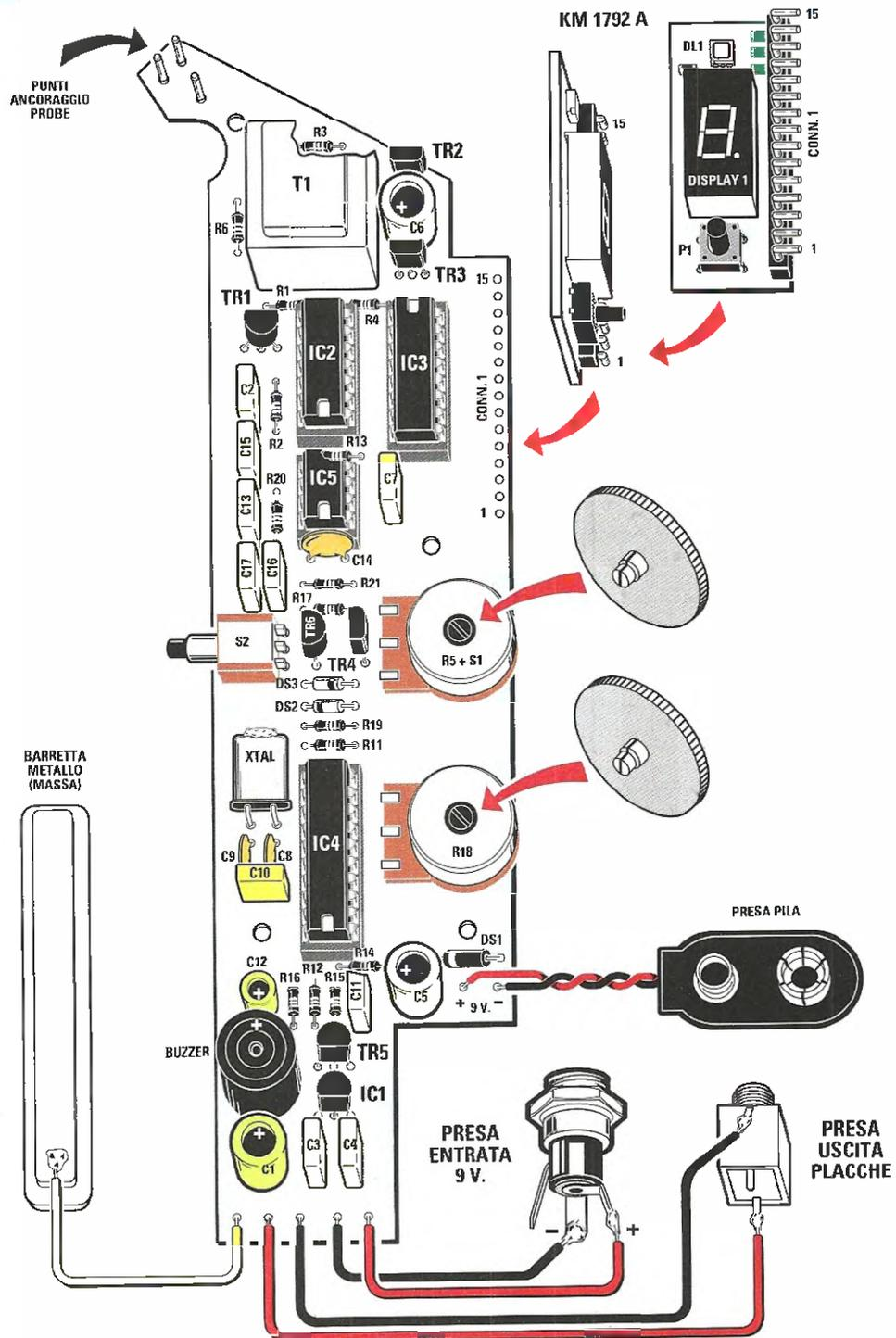
**Fig.7** Schema pratico dell'elettroreflex LX.1792. Come potete vedere il piccolo circuito stampato in SMD KM1792A va innestato su quest'ultimo per mezzo del connettore 15 poli seguendo l'orientamento indicato dalla freccia.
