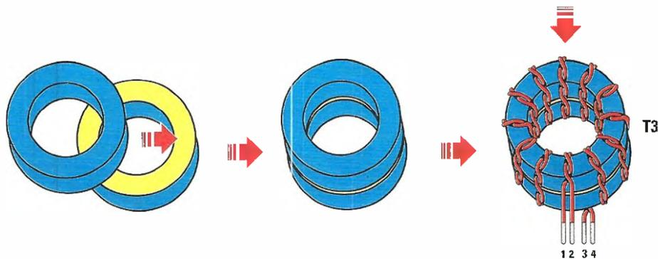
**Fig.12** Per realizzare il trasformatore T3 utilizzate i due nuclei in ferrite di colore azzurro ponendo a contatto le due superfici di colore giallo e avvolgete 12 spire in modo da coprirne in modo omogeneo la superficie.
