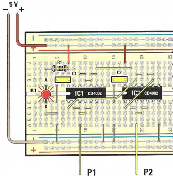
Collegando in uscita una ulteriore porta **invertor**, si ottiene la funzione **NAND** che genera un livello logico di **uscita 0** quando **tutti gli ingressi** sono a **livello logico 1**.
