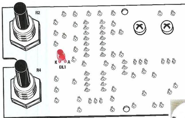
**Fig.6** Disegno dello schema pratico visto dal retro, lato sul quale è previsto il solo montaggio del diodo led DL1.
