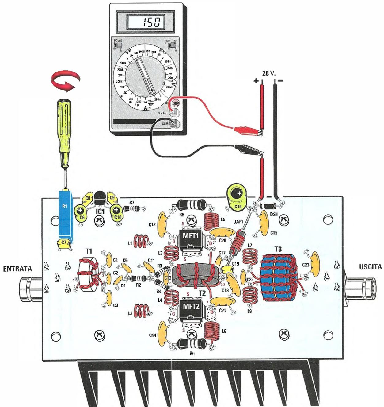
**Fig.16** Prima di applicare la tensione di alimentazione all'amplificatore, bisogna ruotare completamente, nel senso della freccia, la vite di regolazione del trimmer R1. Successivamente, dopo aver collegato l'alimentazione, bisognerà ruotarla nell'altro senso, in modo da far assorbire al circuito una corrente compresa tra i 100 e i 200 milliAmpère.
