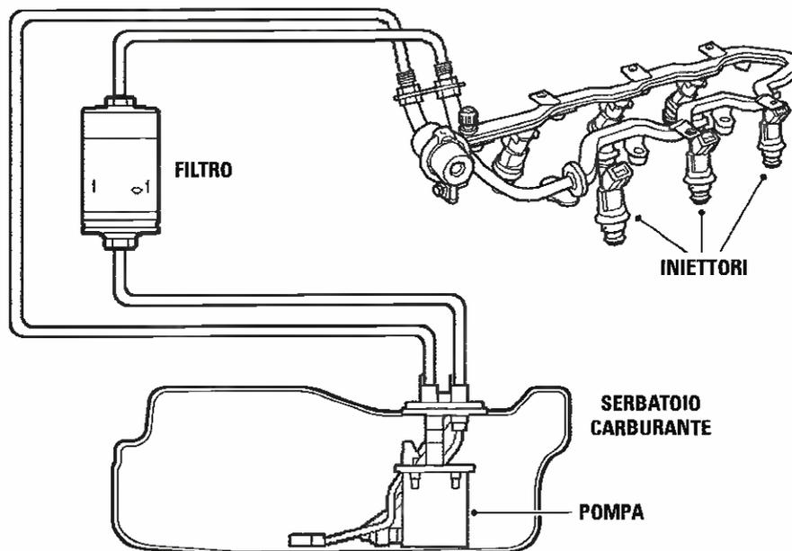
**Fig.9** Nel disegno è schematizzato il circuito di alimentazione carburante presente nelle autovetture dotate di iniettori. Il carburante aspirato dalla pompa viene messo in circolo e ripulito dal filtro prima di giungere agli iniettori.
