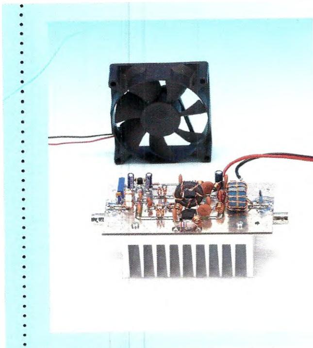
**Fig.17** Nel caso vi troviate a lavorare con potenze di uscita superiori ai 10 Watt e per periodi di tempo piuttosto lunghi, vi consigliamo di direzionare una piccola ventola di raffreddamento verso il circuito e in particolare verso i trasformatori che tendono a surriscaldarsi durante il funzionamento.
