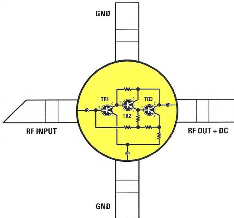
**Fig.1** All'interno del minusclo contenitore è presente un completo circuito di amplificazione composto da diversi transistor per alta frequenza. Il pin di uscita **RFOUT+DC** è comune a quello di alimentazione. Si notino i due pin di massa.
