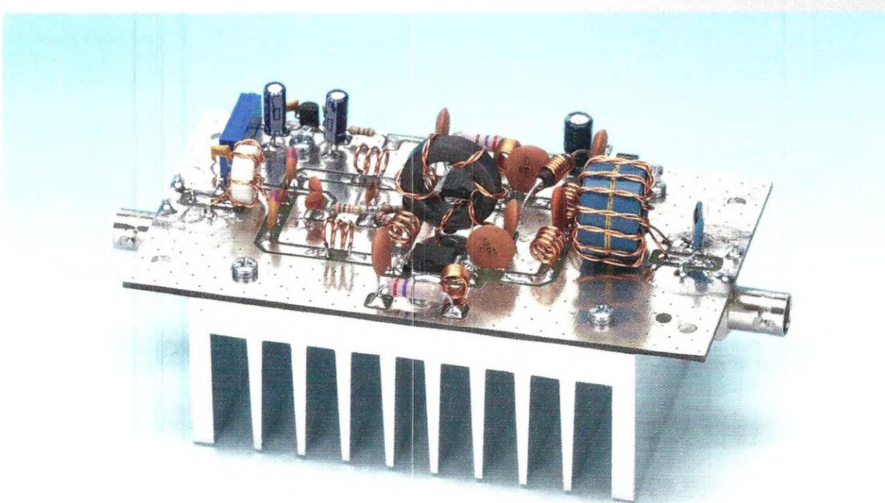
**Fig.1 Foto dell'amplificatore RF a larga banda di potenza.**
