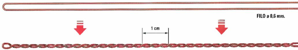
**Fig.9** Per realizzare i trasformatori T1-T2-T3 dovrete innanzitutto realizzare una treciola con del filo dal diametro di 0,6 mm. Come indicazione di massima, 1 cm di treciola è costituita da 3 avvolgimenti (vedi disegno).
