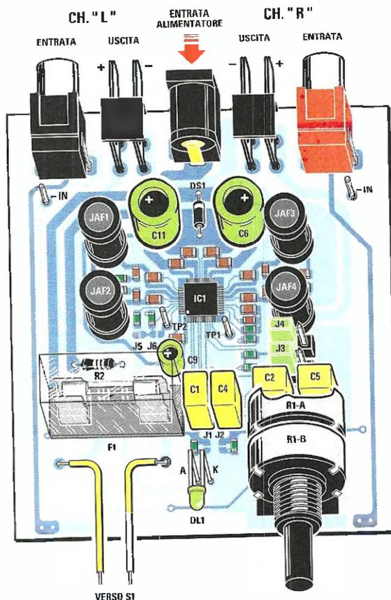
**Fig.16 Schema pratico di montaggio dell'amplificatore in classe D siglato LX.1794.**
