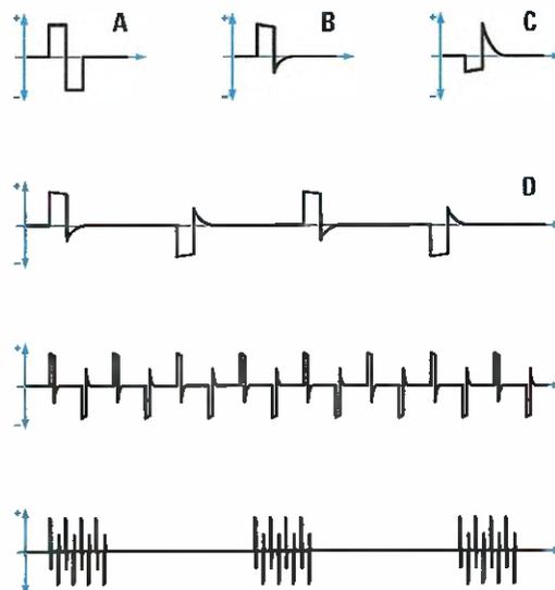
**Fig.10** In alto sono raffigurati in sequenza un singolo impulso di onda bifasica (A), di onda bifasica cinese (B) e di onda bifasica cinese invertita (C). Sotto, come si presenta il segnale emesso dal nostro elettroreflex (D) e, più in basso, come si presenta un treno dello stesso segnale.
