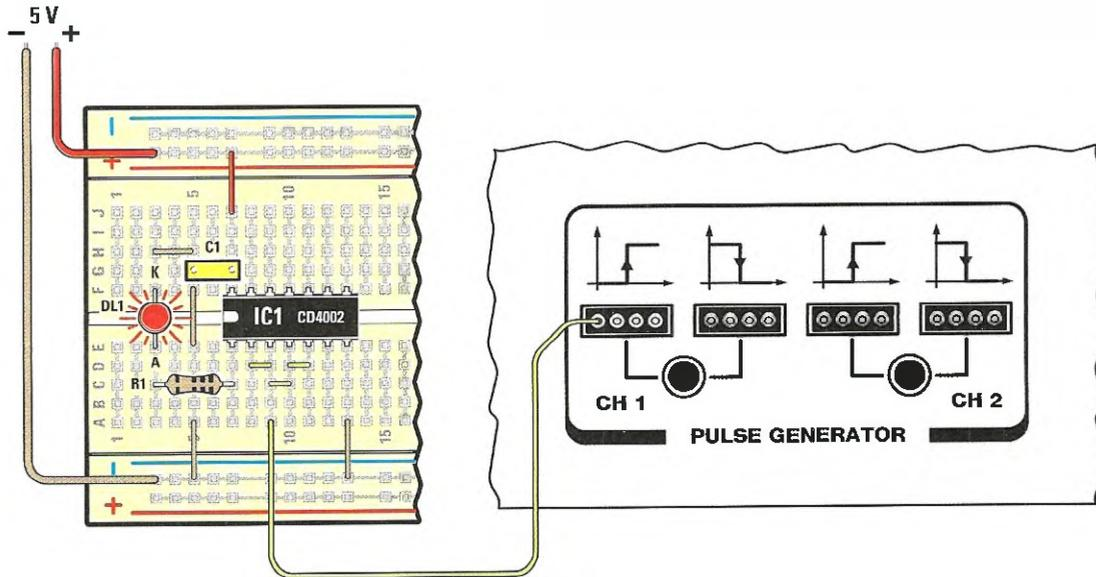
Non dimenticate di collegare inoltre l'uscita del "**Pulse Generator**" all'ingresso del nostro circuito. In particolare, utilizzerete l'uscita **CH1** che genera un livello **logico 1** quando il relativo pulsante verrà premuto e un livello **logico 0** quando sarà in stato di riposo. In questo circuito il **led** deve rimanere acceso quando il pulsante non è premuto e, viceversa, spegnersi quando il pulsante viene premuto realizzando così la funzione **NOT**.
