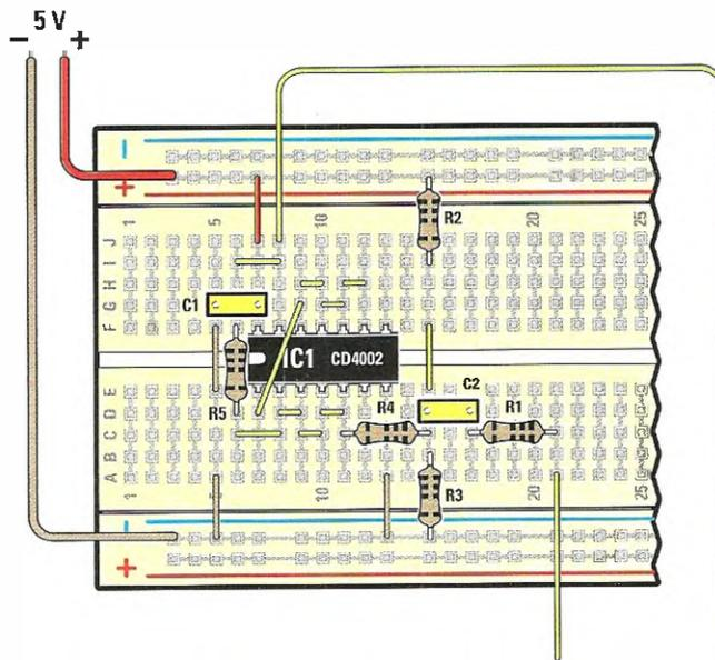
Per realizzare il circuito **squadratore** viene utilizzato un solo integrato **CD4002**, ma alcuni componenti passivi in più rispetto alle altre applicazioni.
