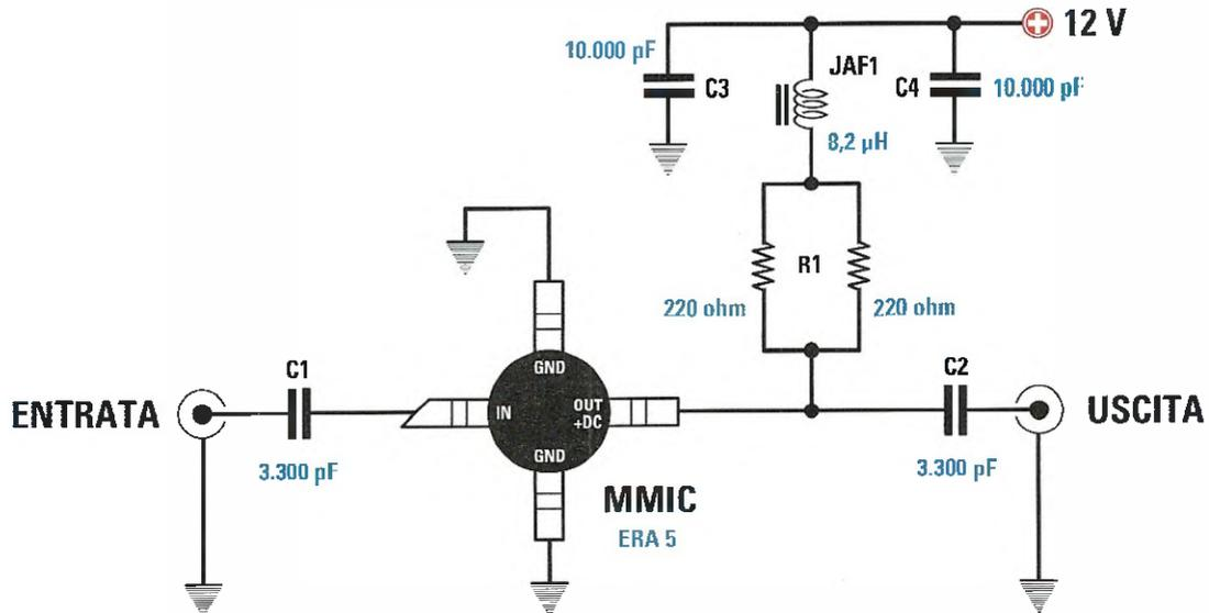
**Fig.8** Aggiungendo in serie alla resistenza di limitazione l'impedenza JAF1 si ottiene un incremento del guadagno e si migliora il ROS di uscita. L'impedenza non deve avere la frequenza di autorisonanza all'interno della banda di utilizzo.
