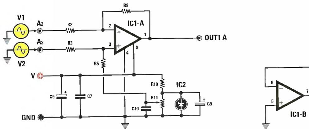
Il disegno rappresenta lo schema di un amplificatore differenziale con alimentazione singola.
