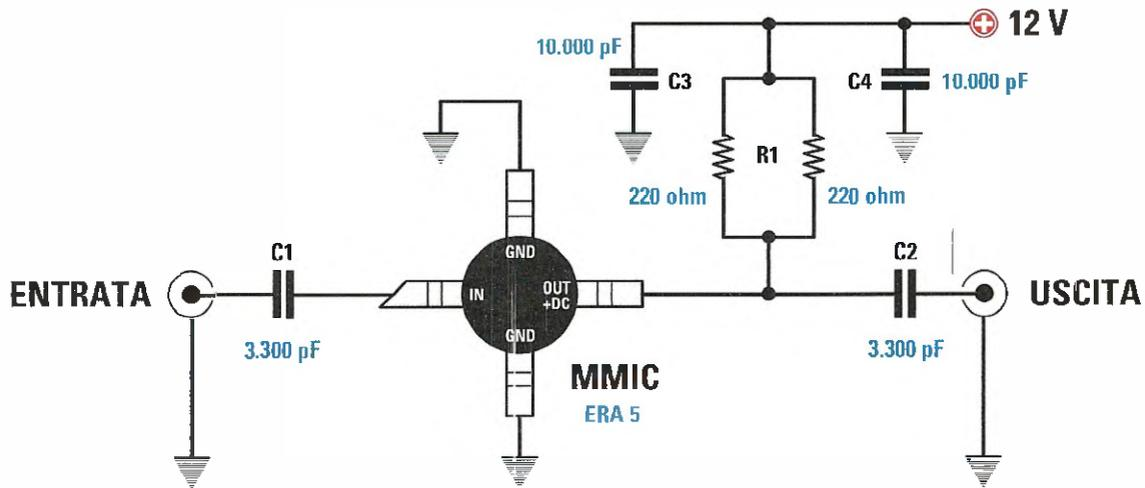
**Fig.4** In questo circuito la limitazione di corrente per il componente MMIC ERA5 è ottenuta dal parallelo delle due resistenze R1 che risultano entrambe da 220 ohm. Si otterrà un valore totale pari a 110 ohm come richiesto dai calcoli effettuati. Aumentando la capacità dei due condensatori C1 e C2 è possibile ridurre la frequenza minima di lavoro dello stadio.
