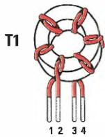
**Fig.10** Per realizzare il trasformatore T1 avvolgete intorno al piccolo nucleo in ferrite di colore bianco 6 spire di filo smaltato distanziandole in modo che si distribuiscano in modo omogeneo sulla sua superficie.
