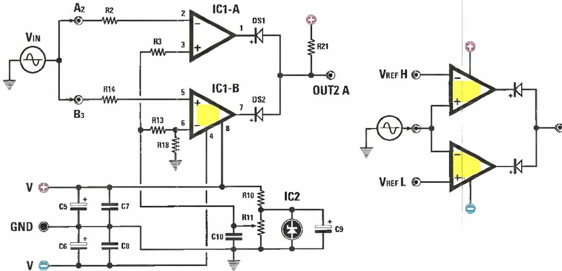
In figura è riprodotto lo schema di un comparatore a finestra. Per capirne meglio il funzionamento conviene osservare lo schema semplificato visibile a destra.
