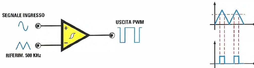
**Fig. 2** Schema di principio e forme d'onda di un modulatore PWM e, a destra, le forme d'onda caratteristiche.
