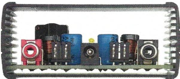
**Fig.17 Foto dell'amplificatore realizzato per i nostri test di laboratorio, inserito nel mobile metallico appositamente predisposto. Qui sopra il circuito inserito nel mobile e visto in sezione frontale e posteriore.**
