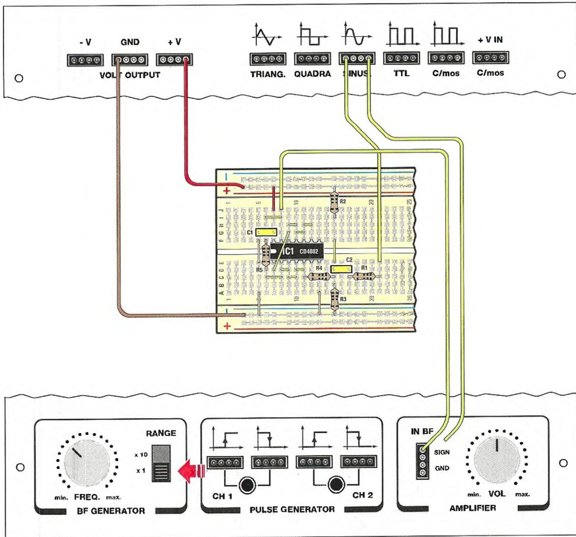
Abbiamo qui raffigurato tutti i collegamenti necessari per realizzare lo **stadio squadratore** e per eseguire la **prova di ascolto** tramite l'amplificatore audio presente all'interno del **minilab**.
