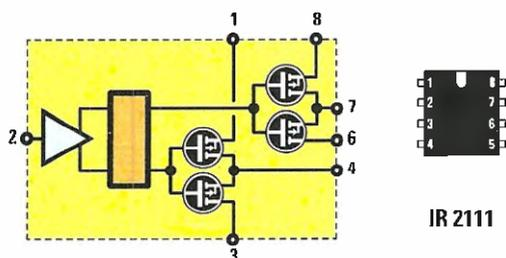
Fig.4 A lato, schema a blocchi dell'integrato IR2111 e relative connessioni con la tacca di riferimento a U orientata verso l'alto.
