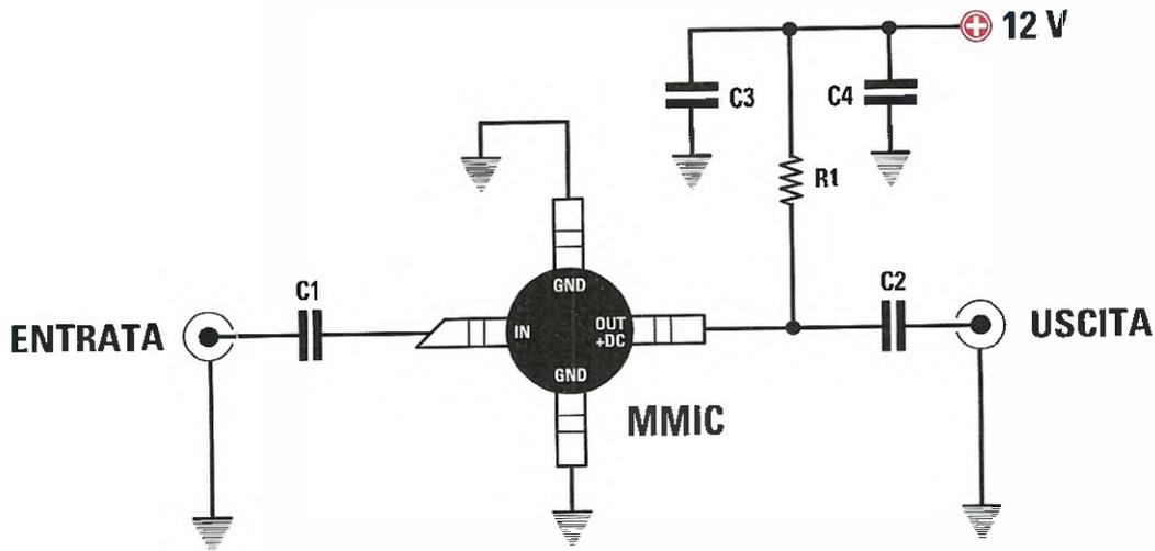
**Fig.3** Lo schema completo di uno stadio amplificatore si riduce veramente a pochi componenti. Tutti i collegamenti e i terminali delle resistenze e dei condensatori devono risultare cortissimi.
