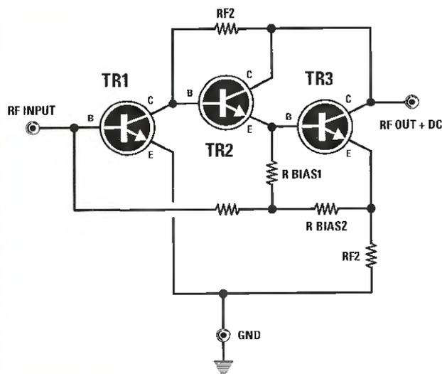
**Fig.2** Schema interno di un tipico amplificatore MMIC.
