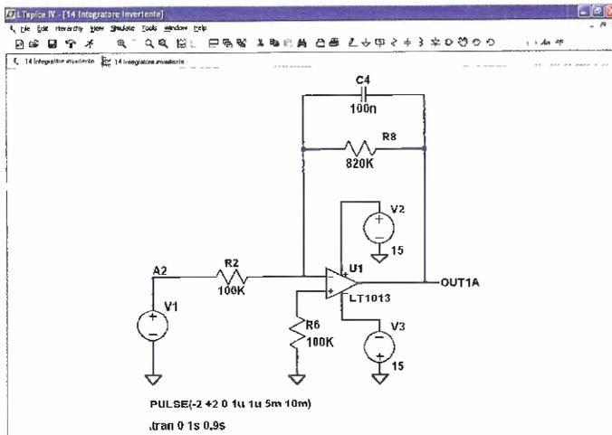
**A lato è riprodotto il circuito utilizzato per la simulazione. Potete vedere i settaggi relativi al generatore e al tipo di simulazione.**
