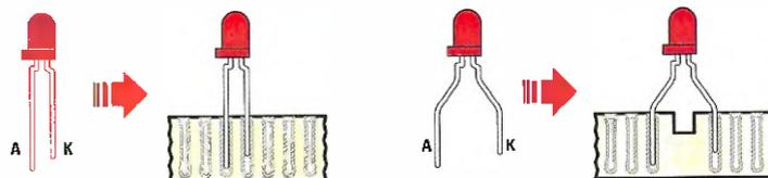
Nell'inserire il **diode LED** dovete fare attenzione alla sua polarità perché, invertendola, non riuscirete a farlo accendere. Il terminale indicato con la lettera **K** è il **Katodo** e va rivolto verso la massa (in pratica verso il negativo dell'alimentatore), mentre l'altro terminale indicato con la lettera **A**, è l'**Anodo** e va rivolto verso la resistenza da **1.000 Ohm**.
