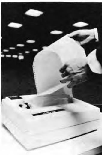
La SARA 10 è una stampante a matrice con caratteri di formato 7 x 7; la velocità di stampa è di 80 cps bidirezionali; le interfacce sono: seriale (EIA-RS232C), 20 mA current loop e parallela.
