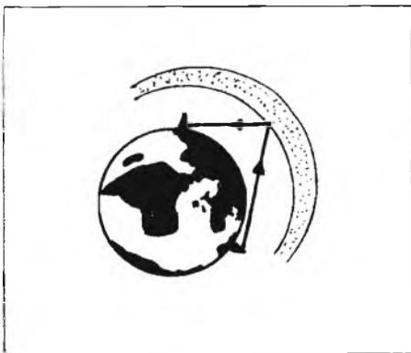
Figura 8 - Mediante la riflessione ionosferica è possibile collegare due punti oltre la curvatura terrestre.
