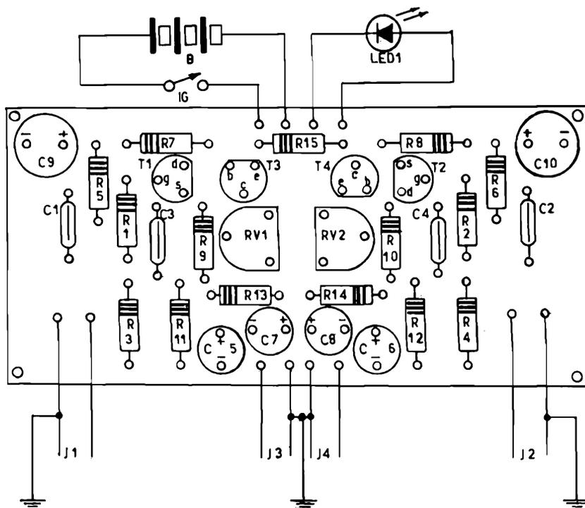
venzionale: l'allestimento del circuito stampato partirà perciò dal fissaggio di tutte le resistenze, dopo di che si potrà procedere con i condensatori non elettrolitici (C1-C4), e delle resistenze variabili RV1 ed RV2. L'operazione successiva potrà consistere nell'installazione dei sei condensatori elettrolitici; per ultimi, converrà installare nelle rispettive posizioni i quattro transistori, facendo molta attenzione alla destinazione dei rispettivi terminali.
