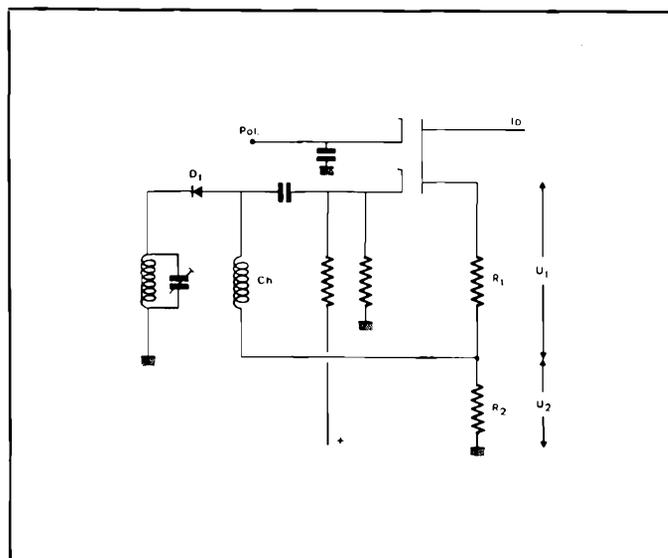
Figura 5 - Variante dello schema dell'amplificatore di figura 4-A, costituita dall'aggiunta al transistor di un diodo del tipo PIN.
