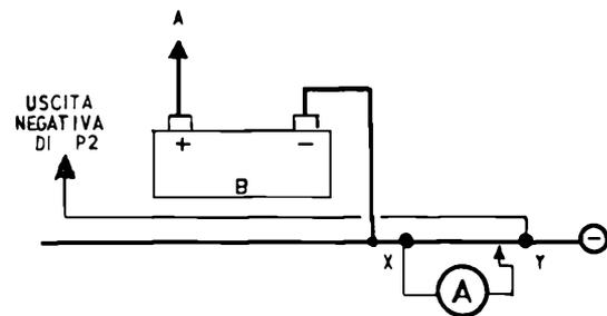
Figura 5-A - Altra modifica che è possibile apportare allo schema elettrico di figura 2-A: si tratta di inserire un milliamperometro da 1 mA fondo scala con l'aggiunta di uno «shunt» tra i punti «X» e «Y», in modo da ottenere una portata ampereometrica totale di 30 A, per controllare sia l'intensità della corrente assorbita dai carichi applicati all'impianto, sia il comportamento del sistema di ricarica della batteria.
