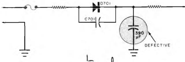
Figura 1-B - Rappresentazione schematica della posizione nella quale si trova il condensatore responsabile del difetto di figura 1-A.
