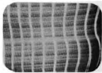
Figura 3 - La presenza di barre verticali e orizzontali in continuo movimento sull'intera superficie dello schermo è dovuta normalmente alla presenza di un condensatore difettoso nella sezione di filtraggio.
