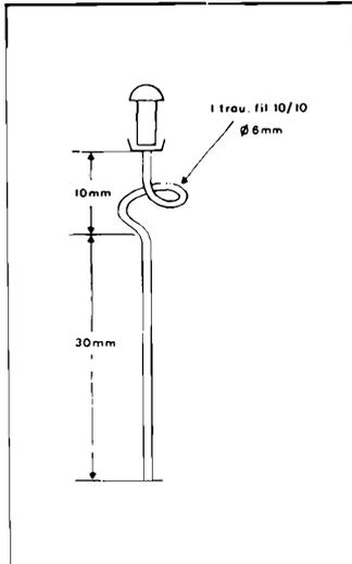
Figura 7 - Tecnica realizzativa delle linee in quarto d'onda a risonanza in parallelo.
