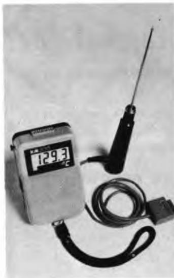
per 10 secondi dopo il rilascio del pulsante di azionamento; funzione valori di picco che permette di valutare i massimi valori raggiunti come di registrare i valori di picco in fenomeni transitori; uscita analogica linearizzata.
