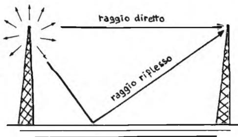
Figura 4 - Modo di propagazione per onda troposferica.
