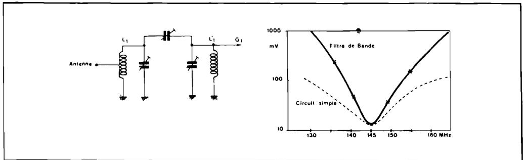
Figura 4 - In A, schema del filtro di banda elementare, in grado di migliorare notevolmente la selettività di ingresso. La curva di selettività ottenibile con l'impiego di questo filtro è rappresentata in B.
