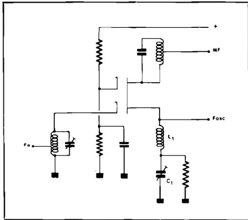
Figura 2 - In questo tipo di miscelatore, la tensione di oscillazione viene applicata sulla stessa sorgente, allo scopo di evitare lo smorzamento del circuito di ingresso a causa della presenza del carico supplementare di uscita dell'oscillatore.
