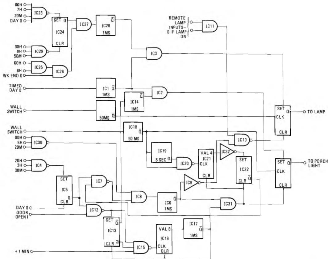
Figura 10 - Schema a blocchi di un sistema di controllo complesso e sofisticato, per provocare automaticamente l'accensione delle luci di un impianto elettrico domestico.
