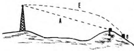
Figura 3 - Collegamento tra due punti non in vista tra loro mediante onde troposferiche. Si noti il percorso curvilineo seguito dall'onda.
