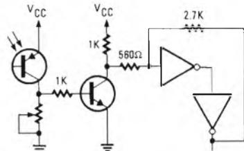
Figura 6 - Esempio di impiego di sensori fotoelettrici per ottenere funzioni di comando automatizzate.
