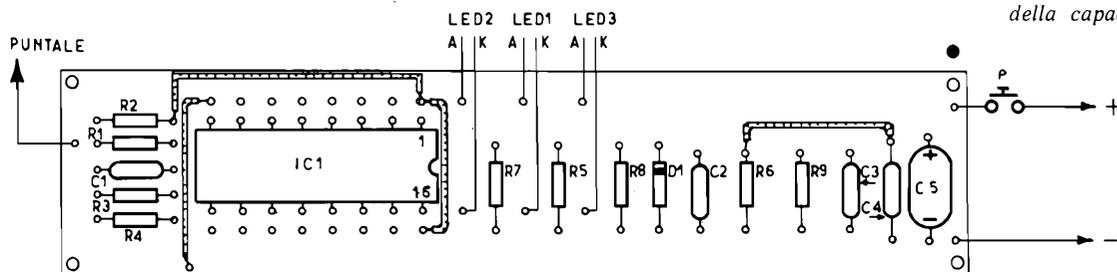
Figura 3 - Riproduzione della stessa piastrina di supporto a circuito stampato, vista però dal lato dei componenti: il puntino nero visibile in alto a destra può essere un utile riferimento per l'identificazione del medesimo angolo rispetto al disegno di figura 2. Si noti l'orientamento del circuito integrato, del diodo D1 e della capacità C5, nonché la polarità dei
