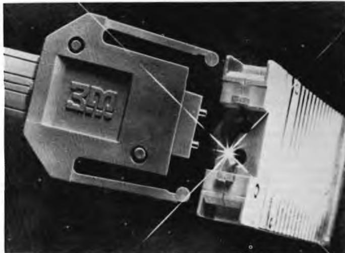
di trasmettere dati sia sincroni che asincroni. Le velocità di trasmissione dei segnali sono quelle tipiche delle logiche TTL e si adattano bene ad applicazioni che richiedono una estesa banda di frequenza.
