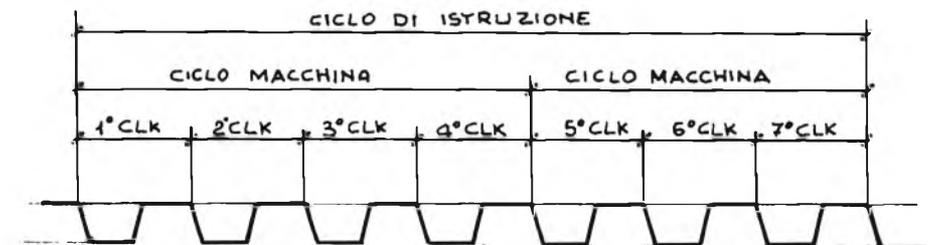
Figura 2 - Relazione fra: ciclo di clock (CLK), ciclo macchina e ciclo di istruzione. Un ciclo macchina comprende più cicli di clock, mentre un ciclo di istruzione può essere formato da 1 o più cicli macchina.
