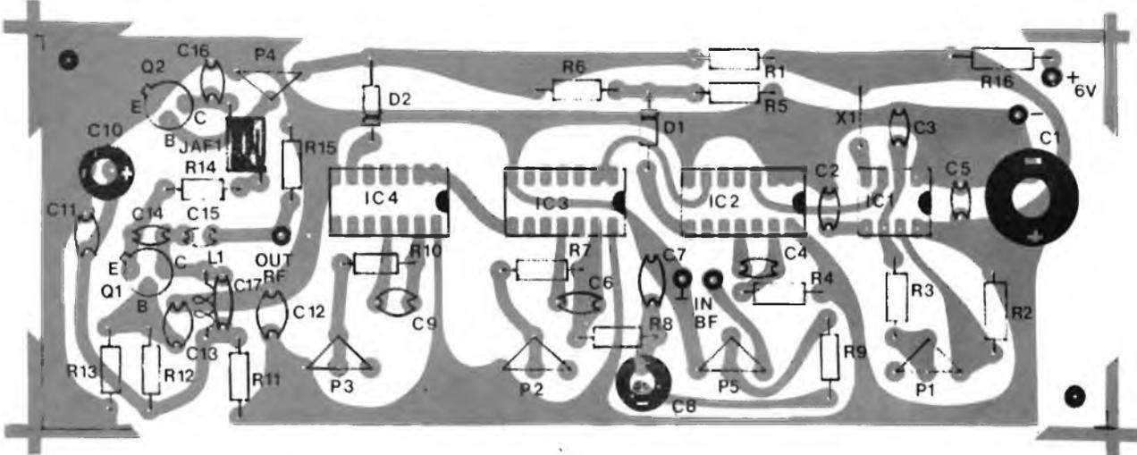
Figura 3 - Piano componenti del « Psico TV » posizionato sulla basetta a circuito stampato riportato in figura 2.
