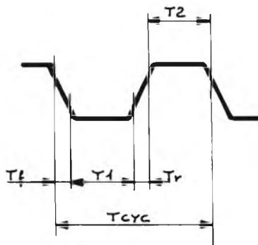
Figura 3 - Caratteristiche dinamiche del segnale di clock:
