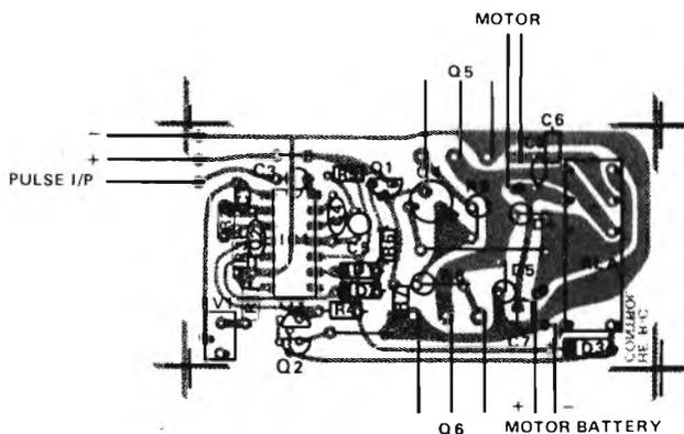
50 Hz, oppure una volta ogni 20 ms. La larghezza centrata dell'impulso può essere variata entro una gamma limitata mediante un controllo di compensazione, che viene abbinato al dispositivo di comando presente sul trasmettitore. Tutte le funzioni logiche vengono svolte da IC1, e dai componenti che ad esso fanno capo: ogni qualvolta viene ricevuto un impulso tramite C3, il circuito integrato produce un impulso di riferimento della du-
