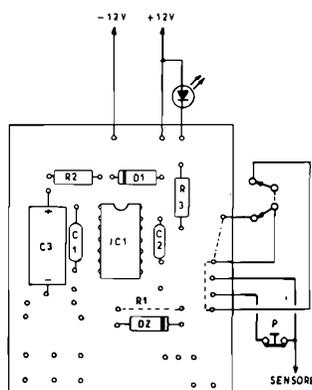
Figura 4 - Veduta dello stesso circuito stampato di figura 3, dal lato dei componenti: il disegno precisa anche i punti di ancoraggio della tensione di alimentazione di  $\pm 12$  V, del diodo LED usato come segnalatore di uscita, del sensore, nonché del pulsante normalmente chiuso P e dell'eventuale gioco di commutazione relativo alla resistenza di riferimento.
