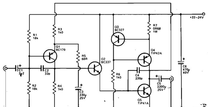
catore è sufficiente una tensione continua monopolare di valore compreso tra 22 e 24 V, positiva rispetto a massa.
