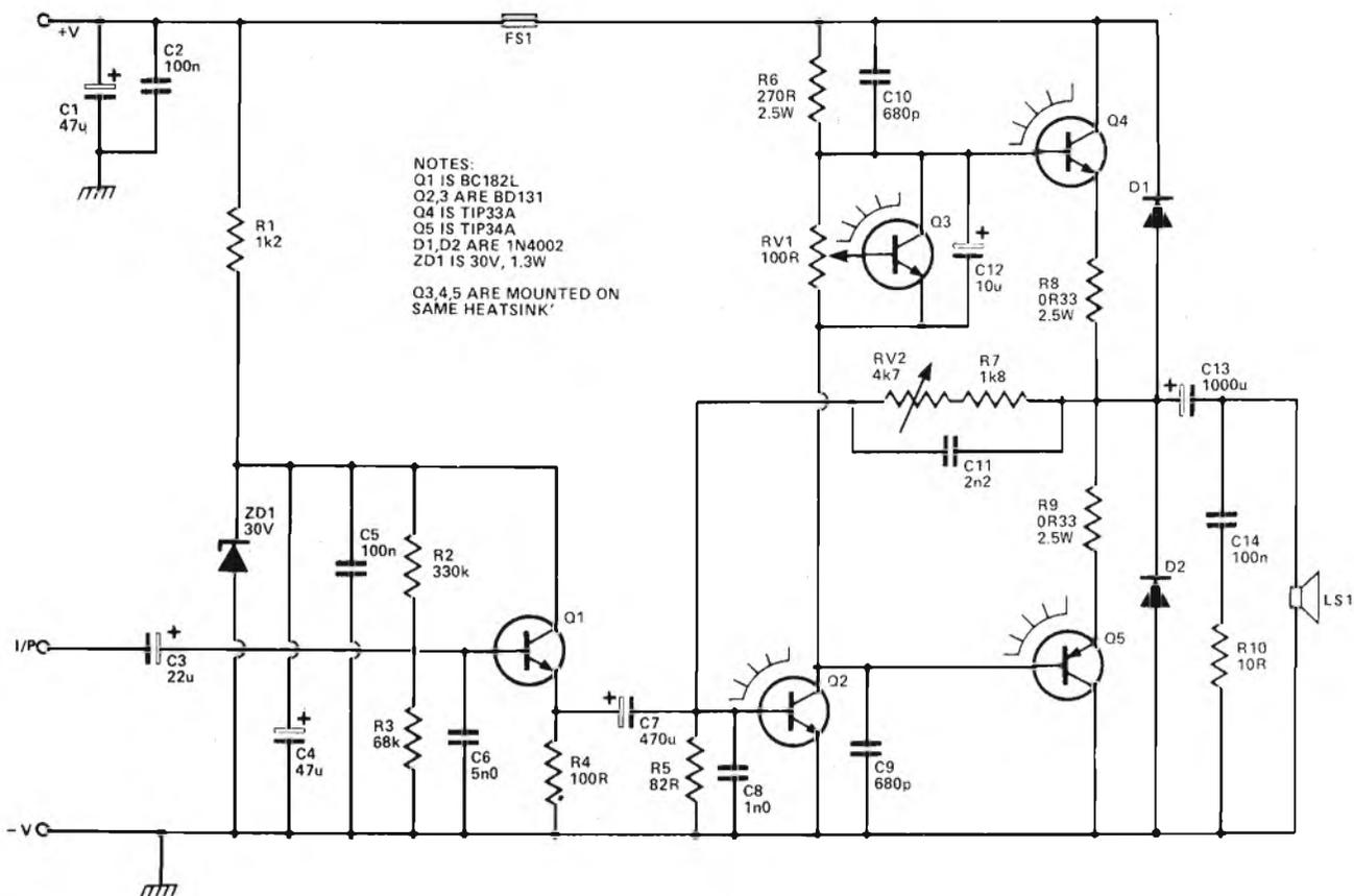
Figura 3 - Schema elettrico dell'intero modulo di amplificazione di potenza, che fa parte dell'intera descrizione.
