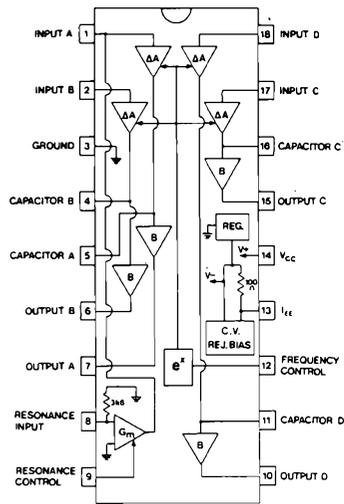
Figura 1 - Rappresentazione schematica del circuito integrato tipo CEM3320, ed indicazione della funzione svolta dai diciotto terminali.
