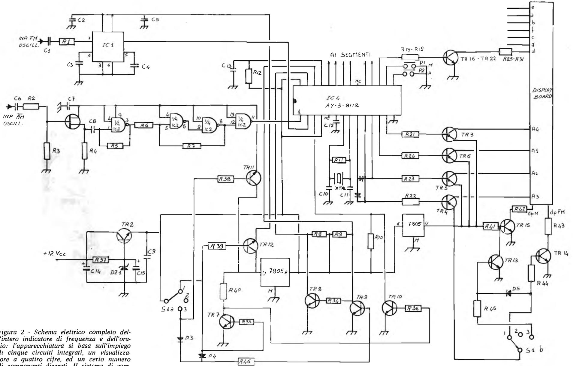
Figura 2 - Schema elettrico completo dell'intero indicatore di frequenza e dell'orario: l'apparecchiatura si basa sull'impiego di cinque circuiti integrati, un visualizzatore a quattro cifre, ed un certo numero di componenti discreti. Il sistema di commutazione permette di visualizzare due diverse gamme di frequenza, oppure l'indicazione dell'ora, attraverso quattro indicatori numerici.
