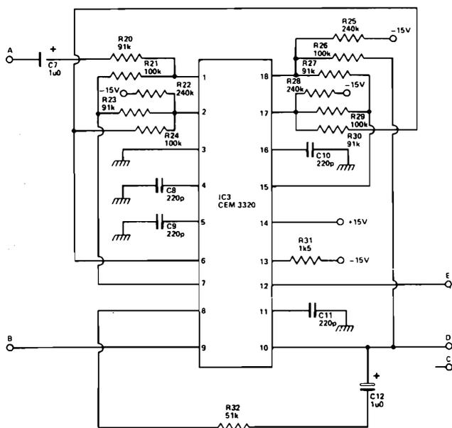
Figura 4 - Questo quarto schema illustra le modifiche che devono essere apportate al circuito per ottenere le caratteristiche di funzionamento «passa-basso».
