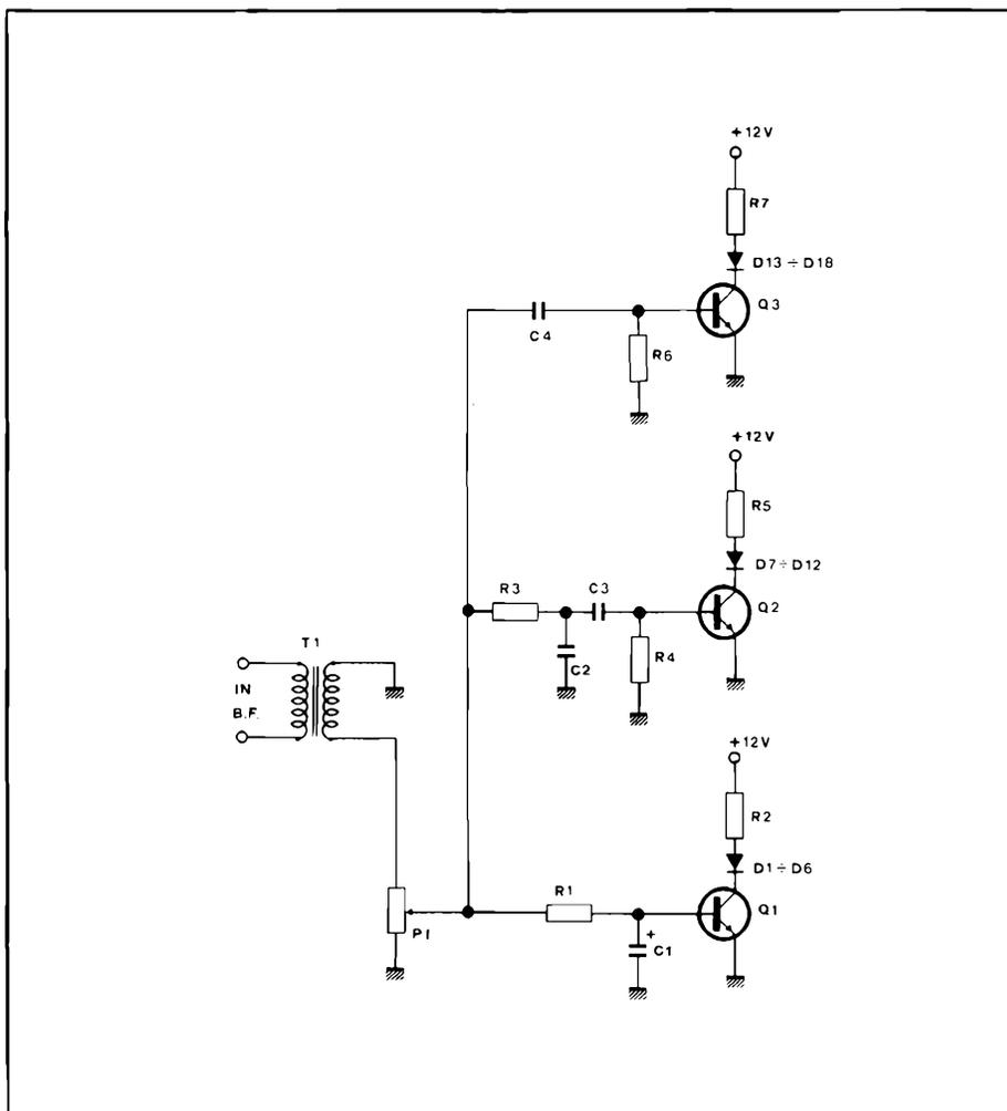
(filtro medi) ed R1/C1 (filtro bassi); il segnale così suddiviso viene inviato ai tre transistori Q1/Q2/Q3 che provvedono ad accendere le tre serie di diodi led. Per accentuare l'effetto psichedelico abbiamo scelto tre colori diversi (rosso, verde e giallo), uno per ogni canale, in modo tale da distinguere perfettamente la differenza di lampeggio tra ogni canale.
