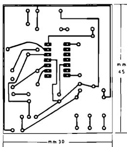
Figura 3 - Lato dei collegamenti in rame del circuito stampato: questa piastrina è stata prevista con una struttura circuitale più complessa di quella effettivamente necessaria, in previsione di dover usufruire del medesimo circuito anche per altre applicazioni descritte alla fine dell'articolo, con l'aggiunta di altri componenti.
