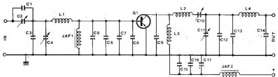
Figura 1 - Schema elettrico della scatola di montaggio dell'amplificatore di potenza che stiamo descrivendo.
