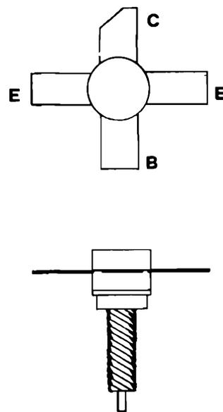
Figura 5 - Rappresentazione grafica delle operazioni da eseguire montando i componenti sul circuito stampato dell'amplificatore di potenza con particolare del transistore finale.
