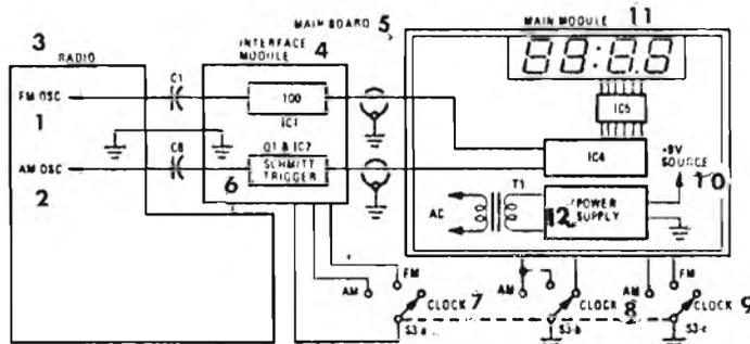
Figura 1 - Schema a blocchi illustrante le diverse funzioni che vengono svolte dal dispositivo, agli effetti dell'indicazione della frequenza FM, della frequenza AM e dell'orario.
