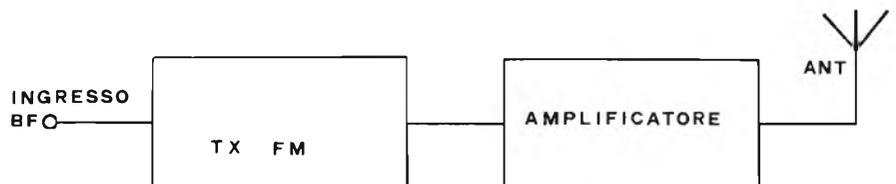
Figura 3 - Esempio di collegamento del trasmettitore FM con l'amplificatore che stiamo descrivendo.
