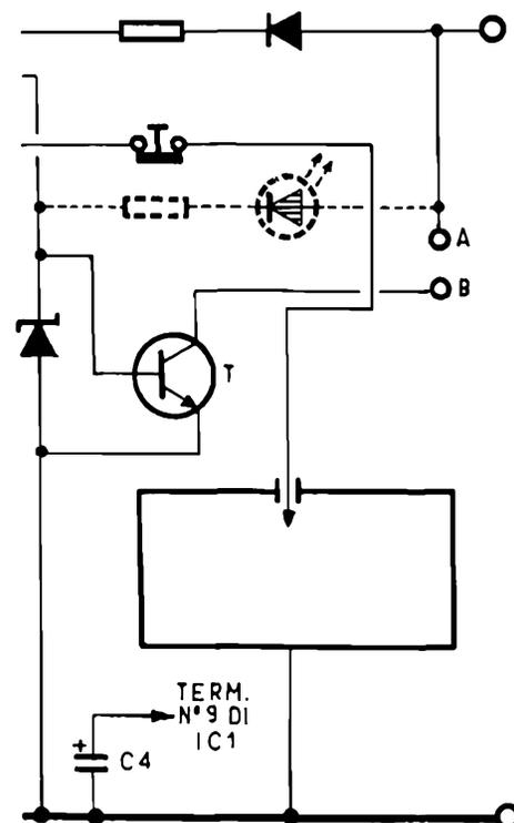
Figura 7 - Nuova riproduzione del lato dei componenti del circuito stampato, con l'aggiunta dei componenti supplementari (T, C4, DT e K) e con l'identificazione dei terminali di alimentazione ( $\pm 12$  V), uscita (A-B) e ingresso (C-D).
