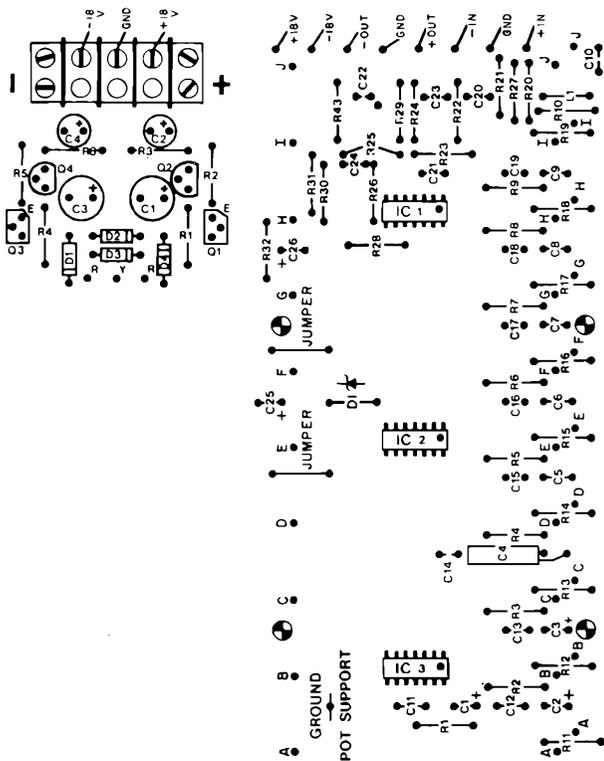
Figura 5 - In alto a sinistra il lato dei componenti del circuito stampato di cui alla figura 3; a destra lato dei componenti del circuito stampato il cui lato rame è riprodotto in figura 4.
