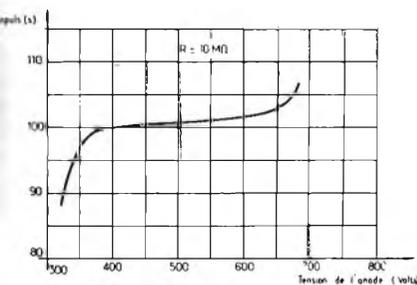
Figura 1 - Caratteristiche essenziali del tubo contatore tipo 18.503.
