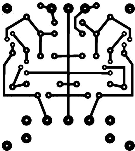
de potenza. Le resistenze comprese tra R20 ed R23 costituiscono uno stadio di ingresso bilanciato di precisione per ottenere un reale effetto differenziale ed un elevato rapporto di reiezione di modo comune nei sistemi a linee bilanciate.
