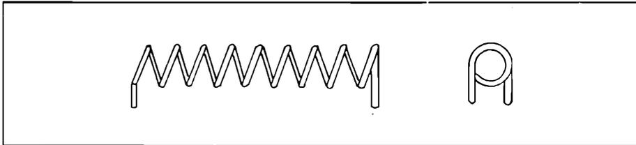
Figura 5 - Riportiamo il disegno della bobina L2, le cui note costruttive sono date nel corso della descrizione per realizzare la lavagna elettronica.
