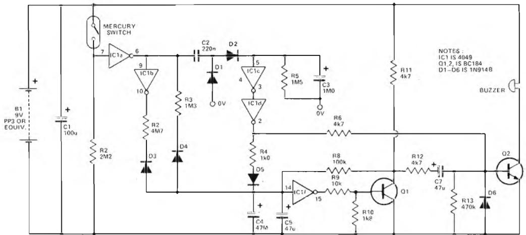
suo compito viene svolto con l'aiuto di un circuito integrato del tipo CMOS, di una coppia di transistori, e di un interruttore a mercurio di tipo molto economico.
