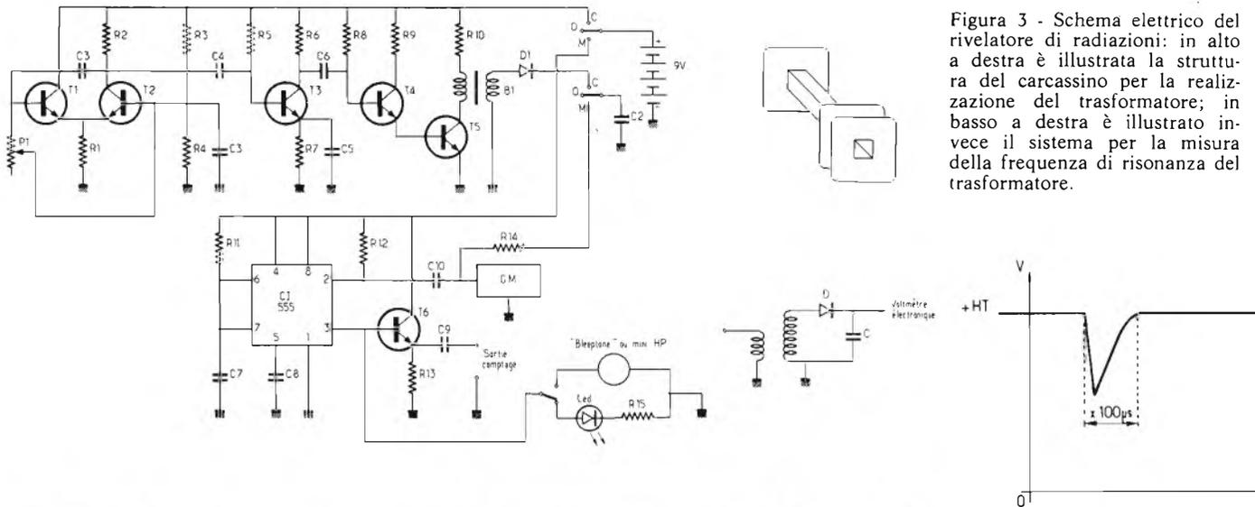
Figura 3 - Schema elettrico del rivelatore di radiazioni: in alto a destra è illustrata la struttura del carcasso per la realizzazione del trasformatore; in basso a destra è illustrato invece il sistema per la misura della frequenza di risonanza del trasformatore.
