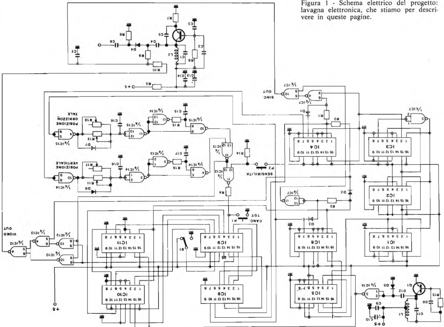
Figura 1 - Schema elettrico del progetto: lavagna elettronica, che stiamo per descrivere in queste pagine.
