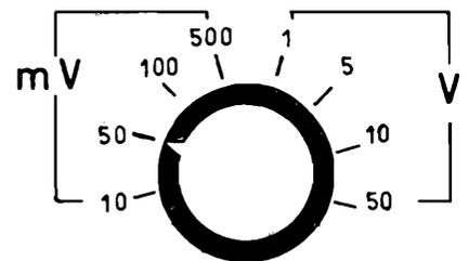
Figura 10 - Se si decide di apportare la modifica di figura 9 allo schema elettrico generale, non è più necessario impiegare il deviatore CO2 per variare la sensibilità: è però necessario sostituire il tipo di commutatore suggerito per CO1 nell'elenco dei componenti con un commutatore rotante a due vie, otto posizioni. In tal caso dal pannello frontale sparisce il moltiplicatore X1 - X10, e il quadrante di regolazione delle portate assume l'aspetto qui illustrato.
