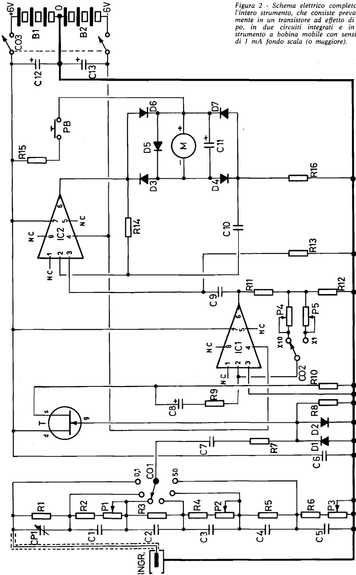
Figura 2.- Schema elettrico completo dell'intero strumento, che consiste prevalentemente in un transistore ad effetto di campo, in due circuiti integrati e in uno strumento a bobina mobile con sensibilità di 1 mA fondo scala (o maggiore).
