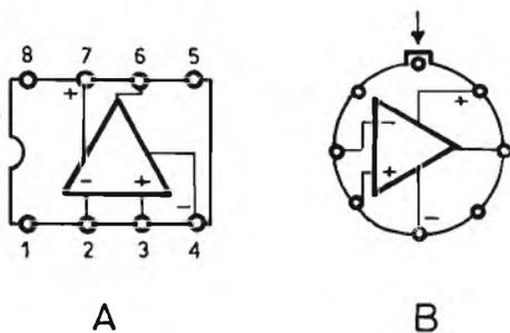
Figura 3 - Il circuito integrato che viene usato in due esemplari in questo strumento è disponibile in due versioni: in A è illustrata la versione « dual-in-line » vista dall'alto, mentre in B è illustrata la versione cilindrica, vista dal di sotto.
