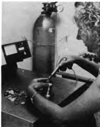
La «Altus Corporation», una fabbrica statunitense di pile al litio per applicazioni in prodotti elettronici di consumo e per altri impieghi in vari settori, impiega un rivelatore di fughe modello 936-70 della Varian al fine di abbreviare i tempi dei test, permettendo di salvaguardare la assoluta integrità del prodotto.
