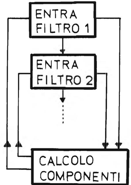
Figura 2 - Svolgimento di un programma per il progetto di un equalizzatore ambientale con l'aiuto di subroutine.
