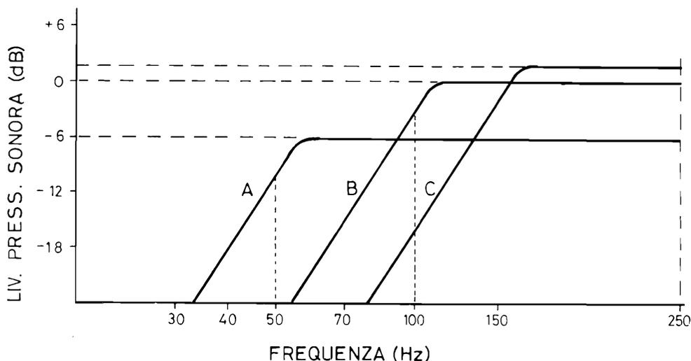
per ottenere quella frequenza di risonanza così bassa era inevitabile sacrificare una parte del rendimento potenziale del trasduttore.
