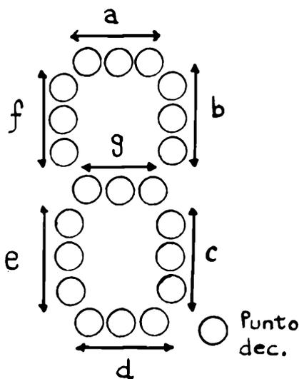
Fig. 2 - Costituzione del display gigante a diodi LED.
