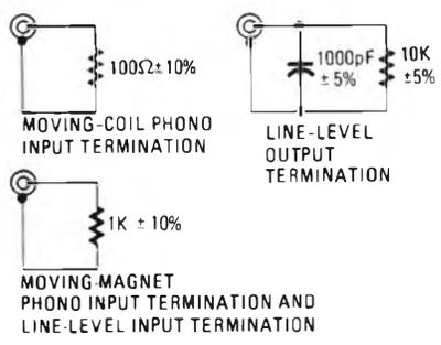
Figura 4 - Schema elettrico di tre tipi fondamentali di ingresso a basso livello e di carico di uscita.
