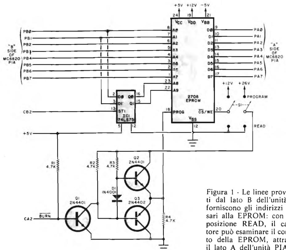
Figura 1 - Le linee provenienti dal lato B dell'unità PIA forniscono gli indirizzi necessari alla EPROM: con S1 in posizione READ, il calcolatore può esaminare il contenuto della EPROM, attraverso il lato A dell'unità PIA.
