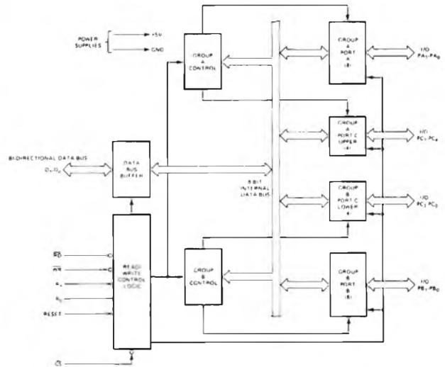
Figura 1 - Configurazione dei PIN e Diagramma a blocchi.
