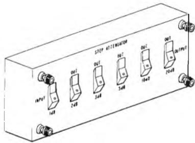
Figura 8 - Esempio di tecnica realizzativa dell'attenuatore a scatti di cui alla figura 7.
