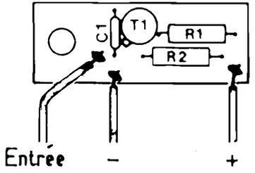
Figura 5 - Nella parte superiore si osservano il lato rame e il lato dei componenti della basetta at circuito stampato su cui può essere montato
