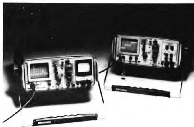
mentati a batteria e molto robusti. Il codello 1502 è uno strumento ad elevata risoluzione (fino ad 1 cm) per medie lunghezze (fino a 600 m) utilizzato per controllare linee di trasmissione su mezzi di trasporto terrestri, marittimi ed aerei, installazioni di antenne ed edifici dotati di moderni impianti di comunicazione.
