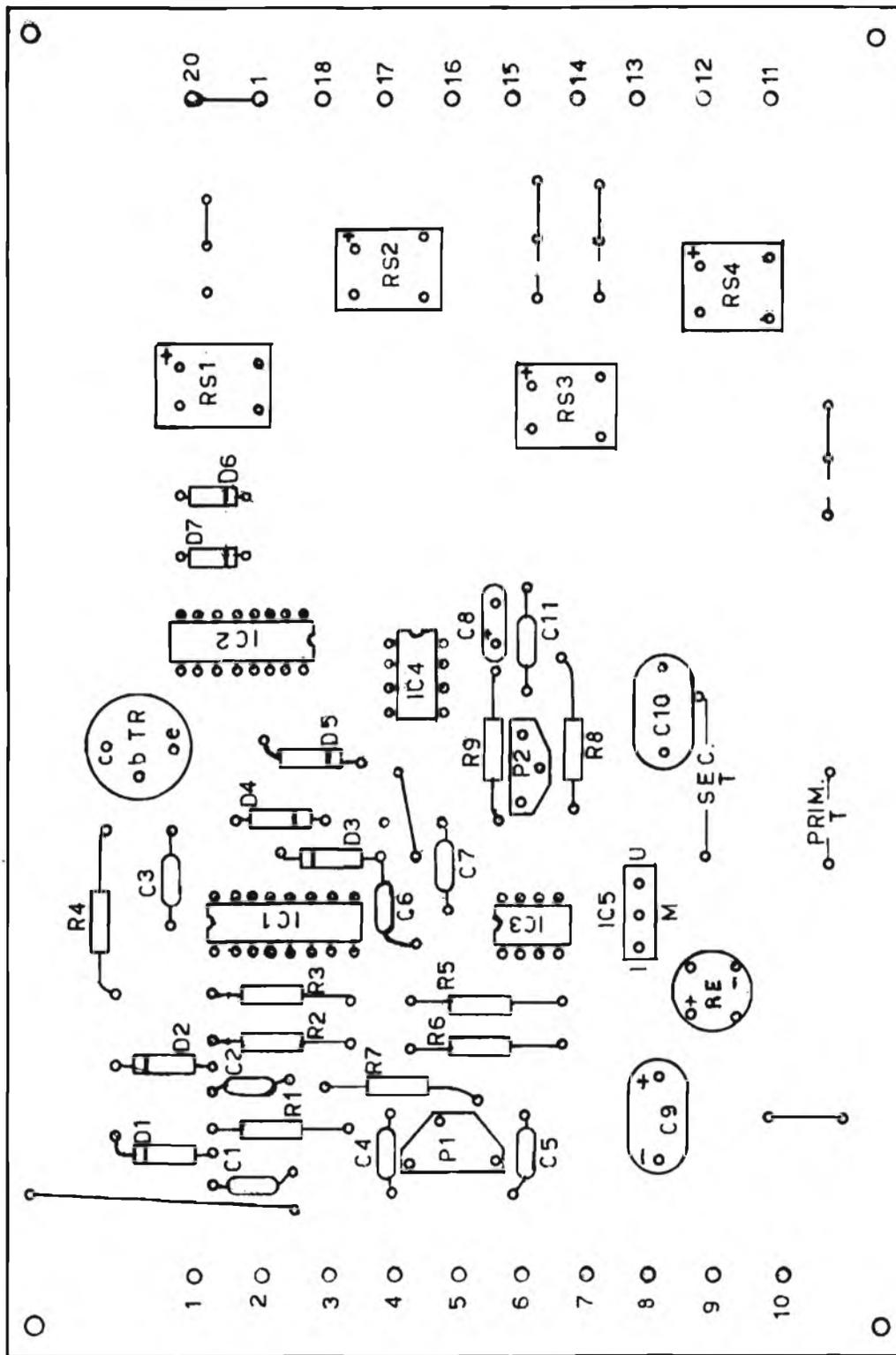
Figura 7 - Veduta dal lato dei componenti dello stesso circuito stampato di figura 6: si noti il puntino nero di riferimento, che consente di orientare questa basetta nella posizione più appropriata, per identificare rispetto al disegno di figura 6 i necessari punti di ancoraggio. Il disegno precisa l'orientamen-
