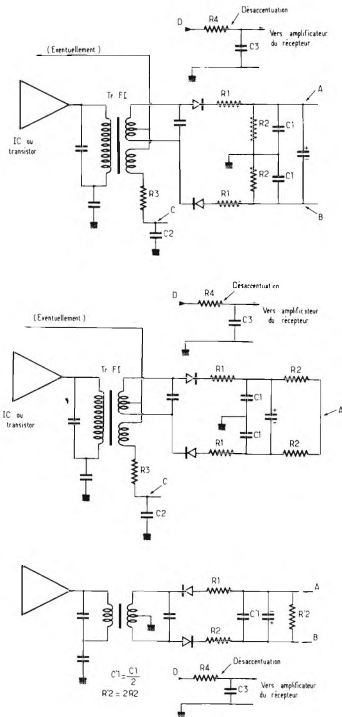
circuito di rivelazione che viene impiegato, allo scopo di ottenere con buona separazione i due canali A e B nel primo caso, un unico segnale monofonico nel secondo caso, ed ancora un segnale stereofonico nel terzo.
