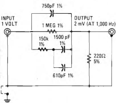
Figura 9 - Schema dell'invertitore di equalizzazione RIAA: i valori dei componenti e le relative tolleranze sono di grande importanza.
