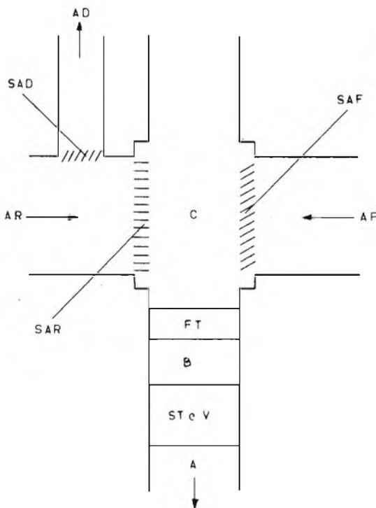
dica ancora il senso di movimento dell'aria consumata o dispersa; SAD rappresenta un sistema meccanico per lo smorzamento dell'aria dispersa, SAF indica un altro sistema meccanico per lo smorzamento dell'aria fresca, AR rap-
