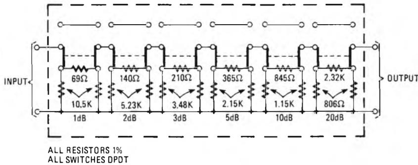
Figura 7 - Schema elettrico dell'attenuatore a scatti: questo dispositivo permette la valutazione dei segnali di uscita con livelli di ingresso predefiniti. I doppi commutatori bipolari possono essere sia del tipo a leva, sia del tipo a bilanciere.
