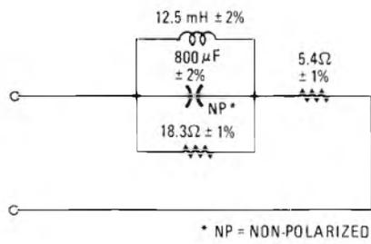
Figura 3 - Carico standardizzato impiegato per la simulazione di un altoparlante. I valori dei componenti non possono essere considerati critici.
