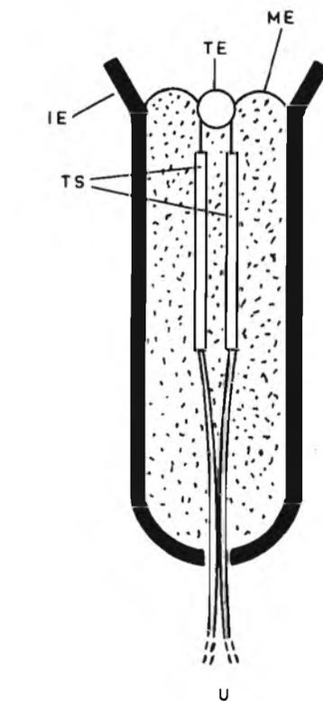
Figura 11 - Tecnica realizzativa dell'involucro contenente i due termistori: si tratta praticamente di creare un involucro esterno protettivo (IE), che racchiude il termistore TE, con l'aiuto del materiale epossidico ME. TS indica i due tubetti steling che si usano per assicurare l'isolamento tra i due terminali che fanno capo all'uscita « U ».
