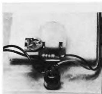
Figura 8 - Particolare del dispositivo per il controllo del grado di umidità del terreno.
