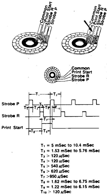
Figura 3 - Diagramma di uscita e ruota dei sincronismi.
