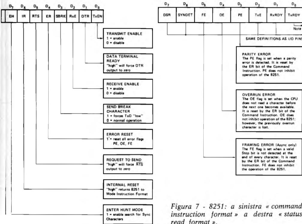
Figura 7 - 8251: a sinistra « command instruction format » a destra « status read format ».
