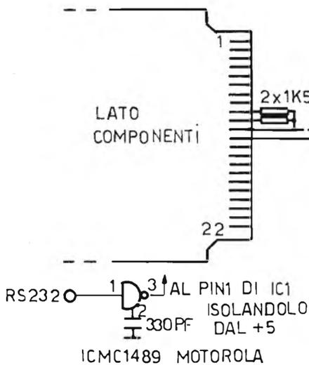
Figura 6 - Collegamento della periferia SM1 per funzionamento seriale, come spiegato nel testo dell'articolo.
