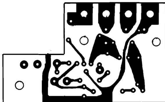
Figura 3 - Vista lato rame del circuito stampato dell'interruttore crepuscolare.
