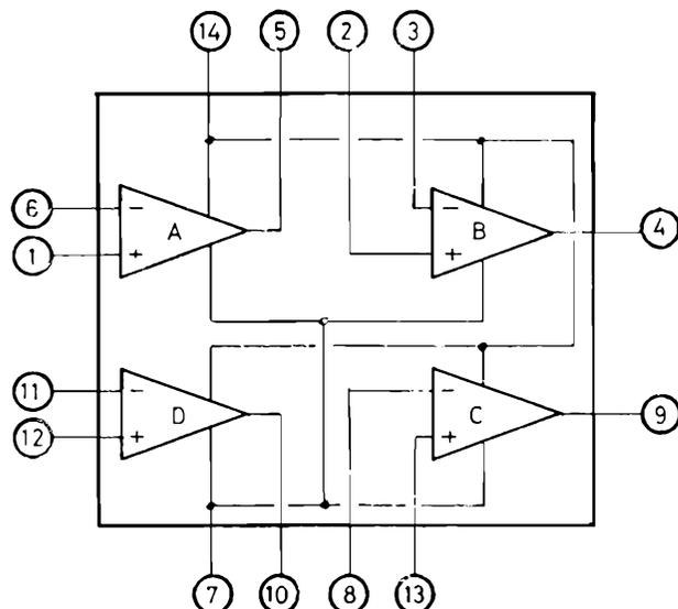
Figura 1 - Schema a blocchi funzionale del circuito integrato costituito dai quattro amplificatori operazionali.
