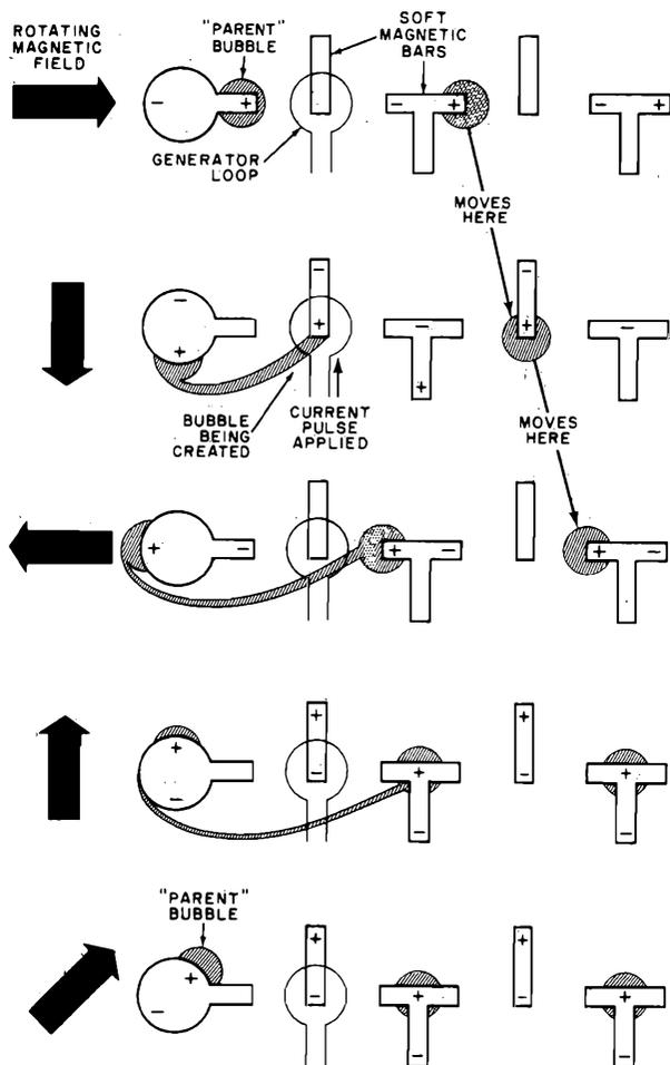
Figura 1 - Una volta realizzata, una bolla ruota tra soffici barre magnetiche ad opera del campo magnetico rotante, rappresentato a sinistra. Le frecce nere indicano appunto il campo magnetico rotante, e, per ciascuna di esse, è illustrata la posizione che la bolla assume a seconda della direzione del campo.
