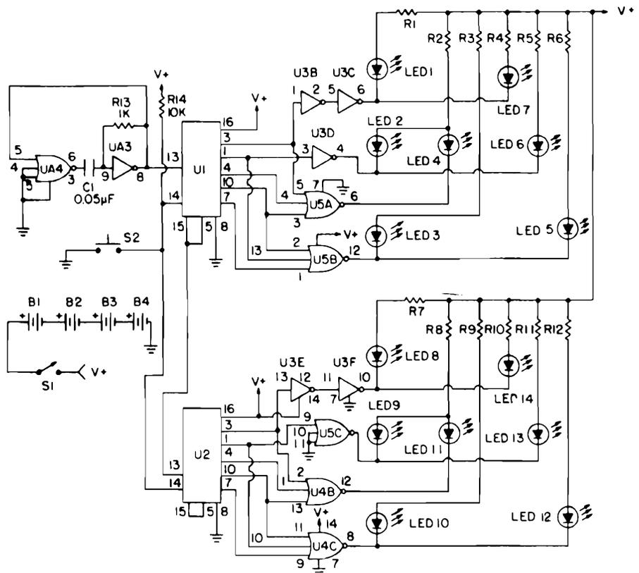
Figura 1 - Schema elettrico completo del gioco elettronico dei dadi, impiegante diodi fotoemittenti in sostituzione dei dadi di tipo convenzionale. Il funzionamento è casuale, e non sono possibili trucchi neppure da parte del costruttore.
