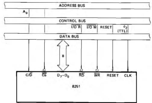
Figura 2 - 8251: interfaccia a bus 8080.
