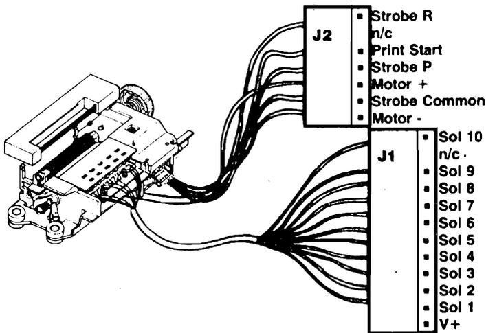
Figura 4 - Collegamento dei connettori della stampante.
