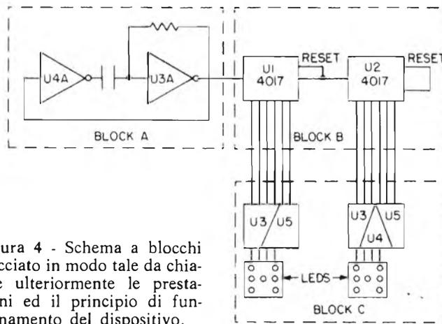
Figura 4 - Schema a blocchi tracciato in modo tale da chiarire ulteriormente le prestazioni ed il principio di funzionamento del dispositivo.
