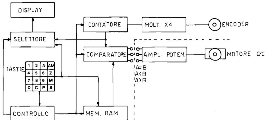
Figura 2 - Schema a blocchi del controllo numerico programmabile.
