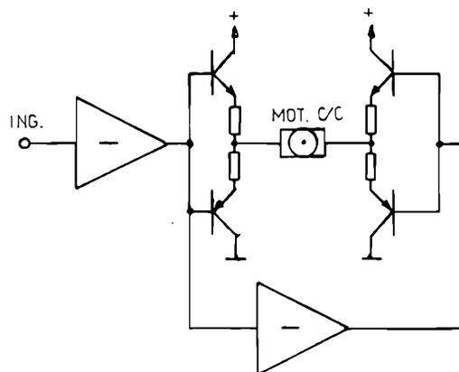
Figura 3 - Stadio di uscita a quadretta del controllo motore.
