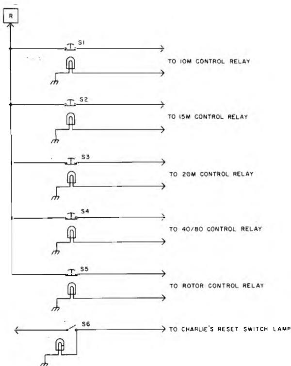
Figura 1 - Schema dei collegamenti fondamentali che fanno capo al relè principale ed al relè secondario.
