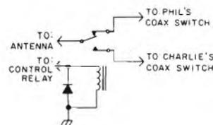
Figure 4 - Circuito semplificato del relè che effettua la commutazione di antenna.
