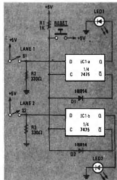
Figura 1 - Schema elettrico del sistema elettronico che costituisce il « giudice di gara » descritto nell'articolo: l'alimentazione è prevista in questo caso specifico al valore di 5 V, e gli interruttori S1 ed S2 rappresentano i dispositivi sensibili al passaggio dei modellini, che possono essere sostituiti con le modifiche descritte nel testo.
