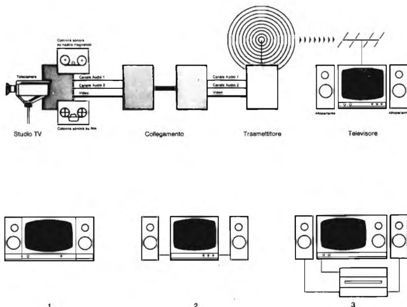
Figura 1 - Nello schema vengono illustrati i modi di trasmissione e ricezione.
