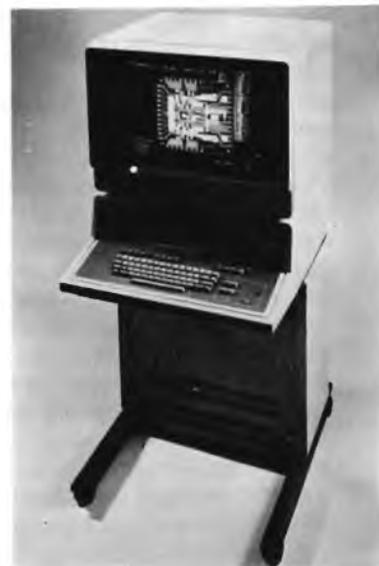
schermo da 19" ed offre la stessa interattività locale del modello con tubo a memoria 4114 e del 4112 a raster-scan. Esso visualizza sullo schermo 640 x 480 punti mentre quelli indirizzabili sono 4096 x 4096, questo permette di eseguire l'ingrandimento di dettagli con possibilità di zoom e pan locali. Invece di lavorare su piccole parti di mappe o schemi complessi, come è normalmente necessario con gli schermi a colori di media risoluzione, è possibile operare sulle immagini complete.
