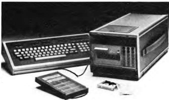
za un processore a 16 bit, è stato progettato dagli ingegneri della Tektronix per poter venire interfacciato facilmente con strumenti e periferiche IEEE-488.
