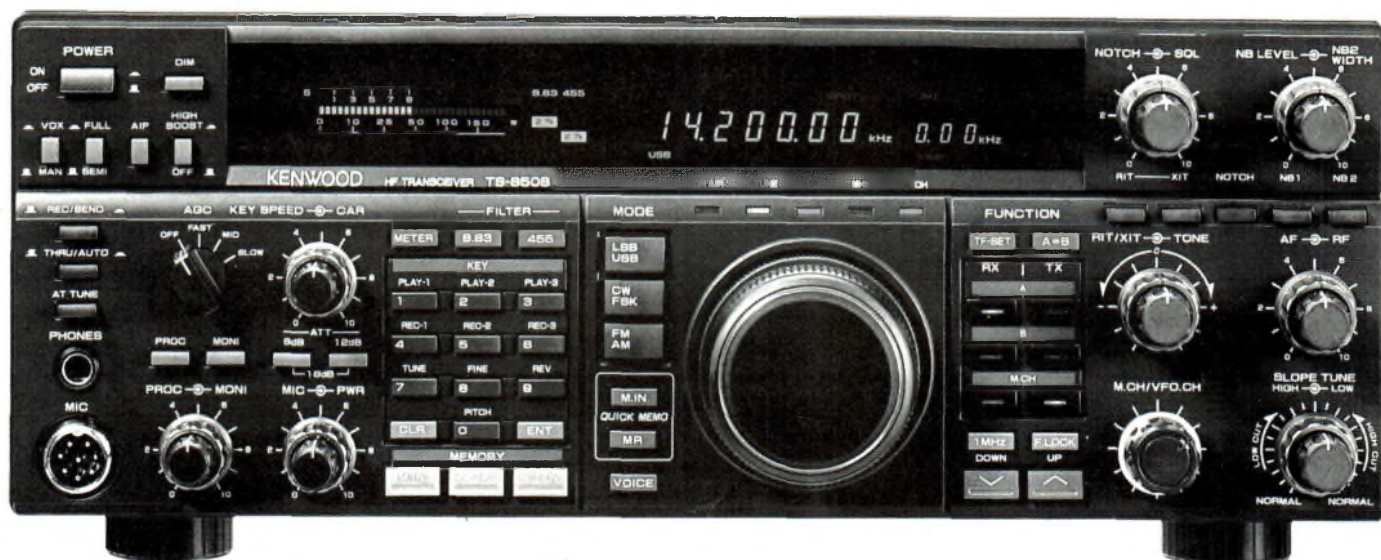
Un transceiver haut-de-gamme comme ce TS-850, possède une multitude de filtres pour la réception.
