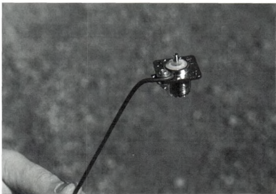
Détail de la fixation des radians.
